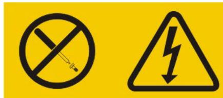
In Komponenten, die dieses Etikett aufweisen, treten gefährliche Spannungen und Energien auf. Diese Komponenten enthalten keine Teile, die gewartet werden müssen. Besteht der Verdacht eines Fehlers an einem dieser Teile, ist ein Kundendiensttechniker zu verständigen.
