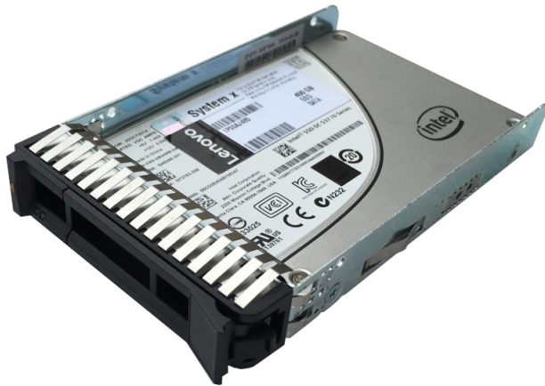
Figura 32. SSD SATA Enterprise performance S3610 en un factor de forma de intercambio en caliente de 2,5 pulgadas
