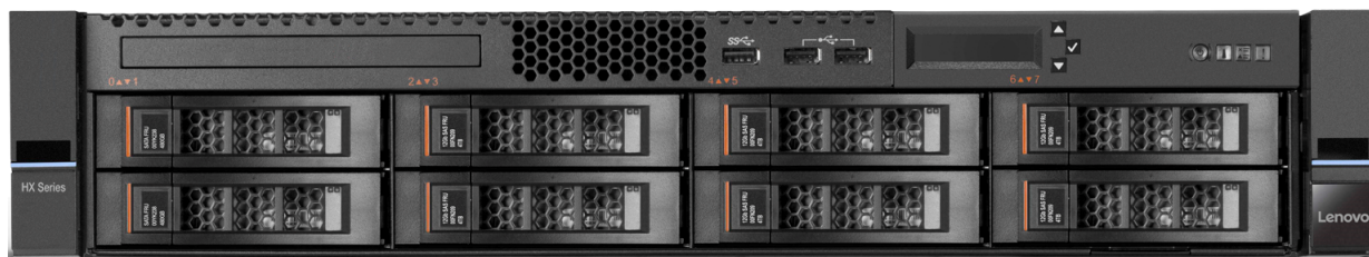
Figura 6. Vista frontal de configuración de ocho unidades de 3,5 pulgadas HX5510 y HX5510-C
