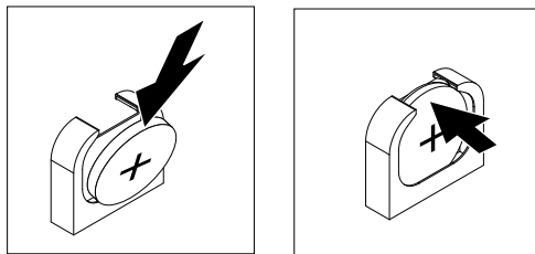
Figure 140. Installation de la batterie à pile cellulaire
