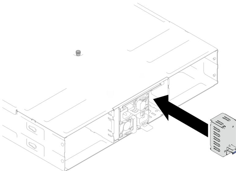
Figura 23. Instalação de um preenchimento de PSU
