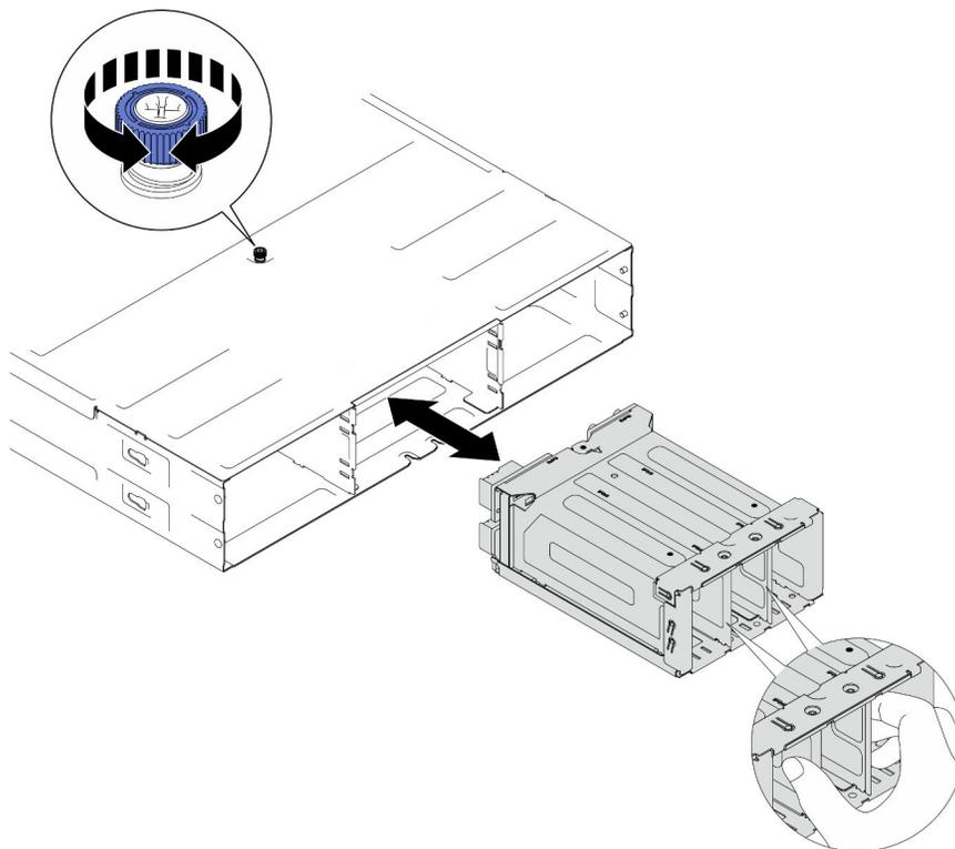
Figura 29. Instalação da gaiola de PSU
