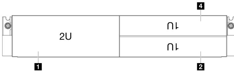
Figura 5. Vista frontal do chassis com um nó 2U (bandeja esquerda) e dois nós 1U (bandejas à direita, de cabeça para baixo)
