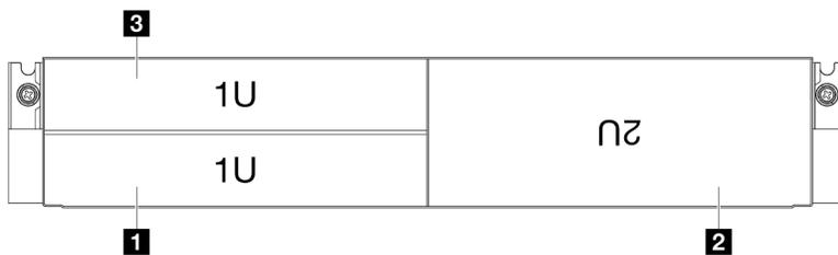
Figura 6. Vista frontal do chassis com dois nós 1U (bandejas à esquerda) e um nó 2U (bandeja à direita, de cabeça para baixo)
