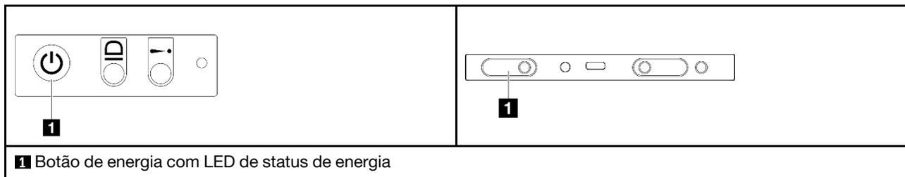
Para colocar o sistema em estado de espera (o LED de status de energia pisca uma vez por segundo):
