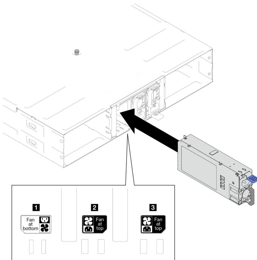
Figura 25. Instalação de uma fonte de alimentação hot-swap
