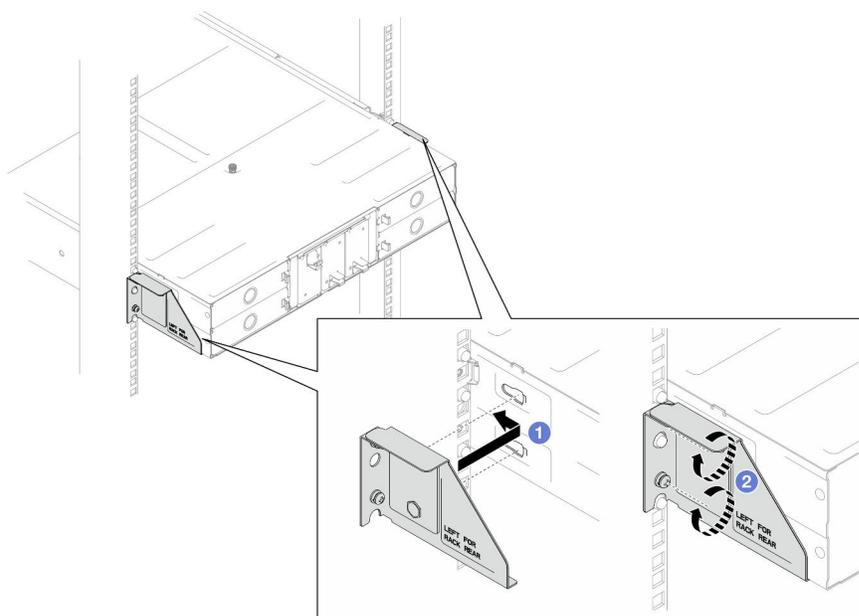
Figura 19. Instalação dos suportes de remessa
