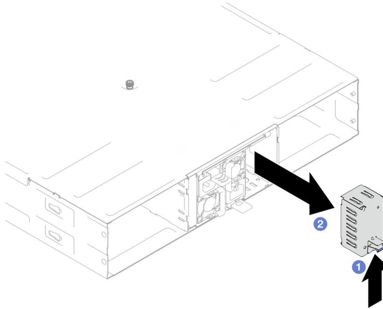
Figura 24. Remoção de um preenchimento de PSU
