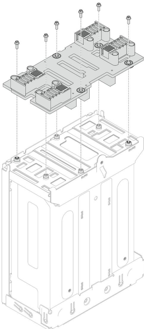
Figura 28. Instalação do painel intermediário do chassi
