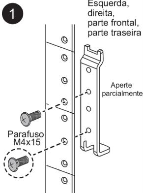
Não instale este parafuso nos suportes frontais para todos os sistemas e prateleiras de unidades 2U. Ele será instalado depois que o equipamento esteja no lugar.
