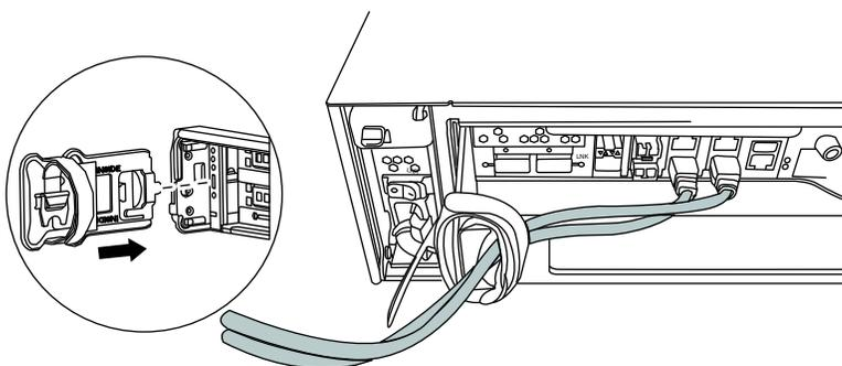
步骤 4. 如果在拔下线缆之后将 SFP 模块留在了系统中，请将这些模块移到新控制器模块。
