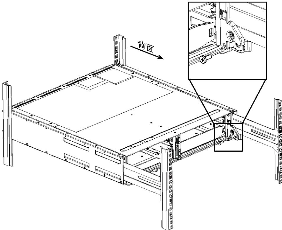
步骤 7. 适用的情况下，装回存储架端盖或系统挡板。
