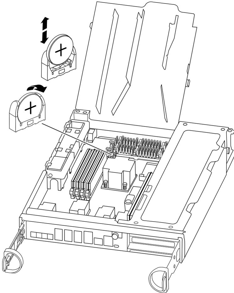
**步骤 3.** 轻轻地将电池推离电池座，将其从电池座上旋开，然后将其提起并从电池座中取出。
