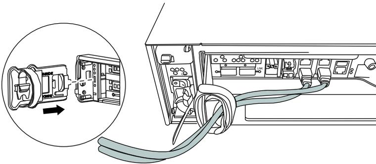
步骤 4. 拧松控制器模块的凸轮手柄上的指旋螺钉。
