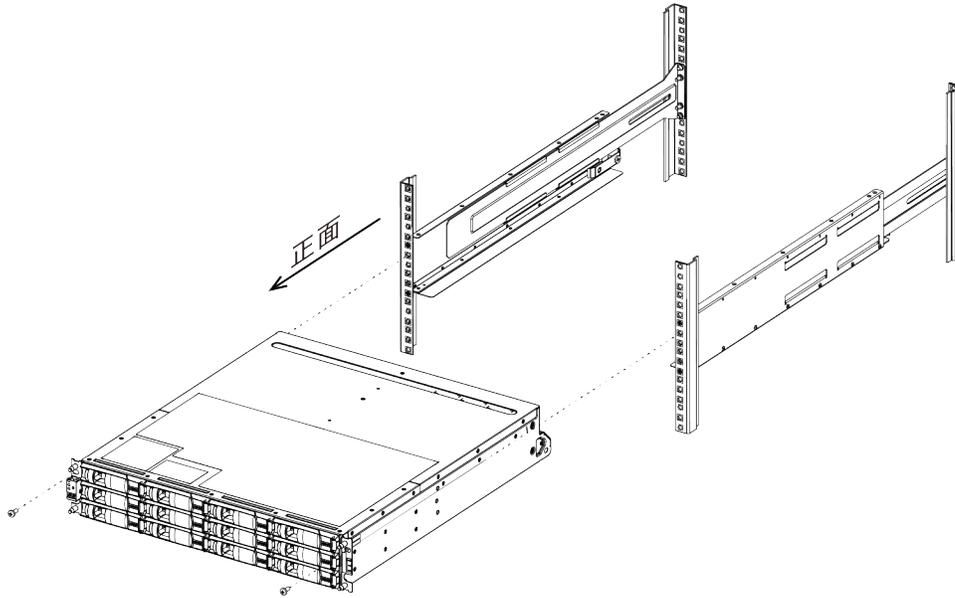
步骤 6. 将两颗 M5 螺钉穿过机柜上的支架和导轨套件支架，从而将机柜固定到导轨背面。
