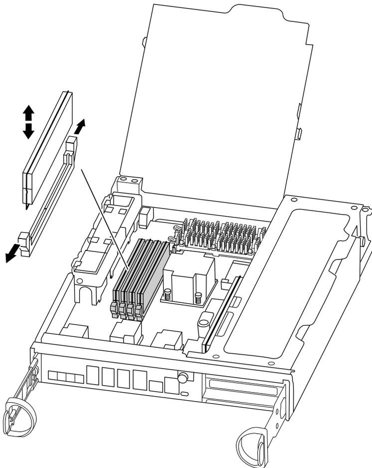
步骤 9. 从防静电包装袋中取出替换 DIMM，捏住 DIMM 的边角，并将其对准插槽。DIMM 上的引脚之间的槽口应与插槽中的卡扣对齐。
