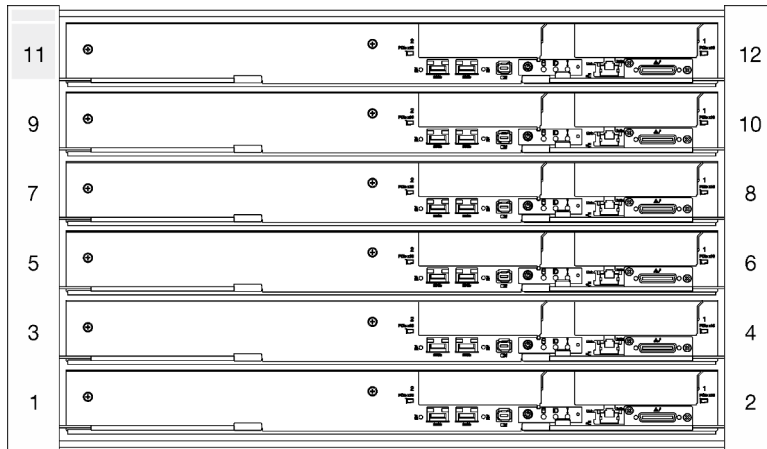
Abbildung 7. DW612S Gehäuse mit sechs SD650-I V3 Servern
