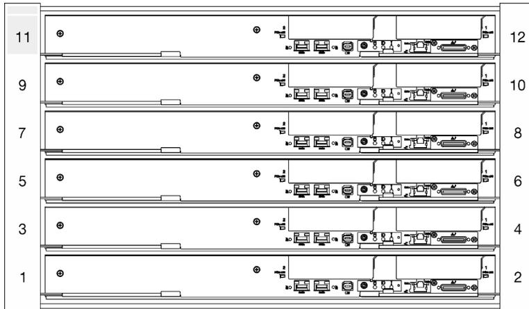
Abbildung 7. DW612S Gehäuse mit sechs SD650-I V3 Servern
