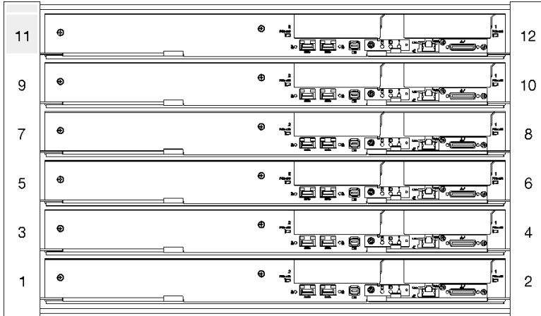
図 7. 6 個の SD650-I V3 サーバーを備えた DW612S エンクロージャー
