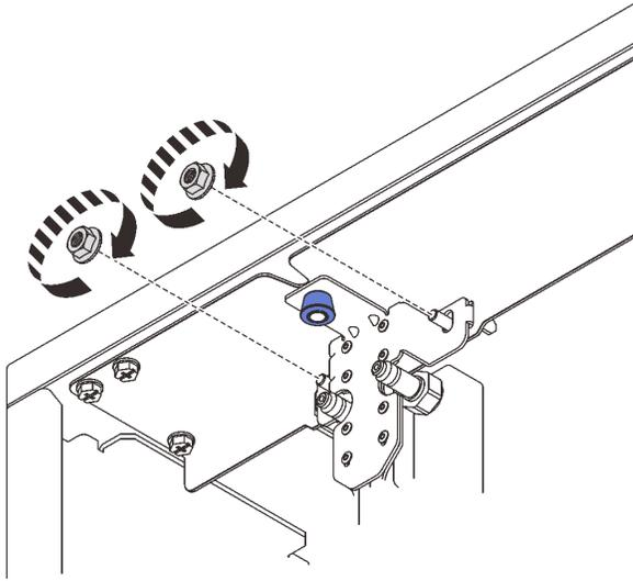
**그림 68. 상단 랙 매니폴드 마운팅 브래킷 너트 설치**
