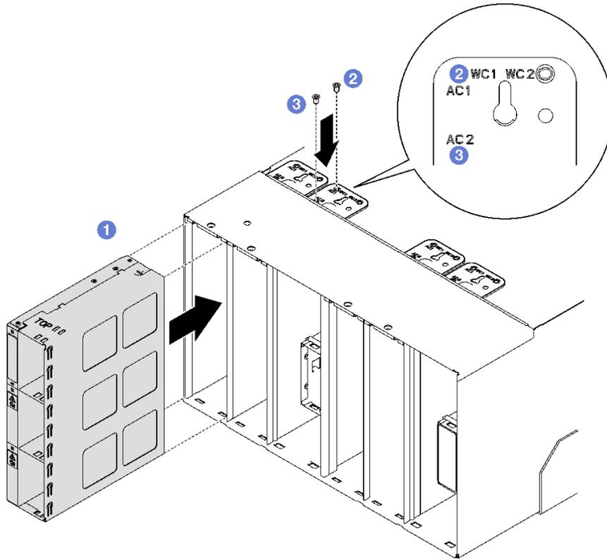
그림 128. PSU 케이지 설치
