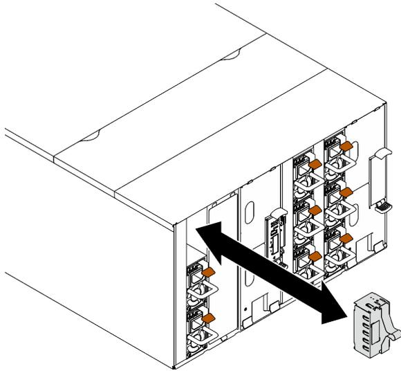
**그림 98. PSU 필터 설치**
