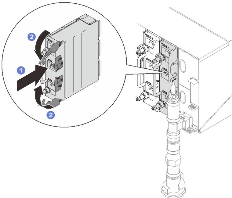
**그림 84. DWC 전원 공급 장치 설치**
