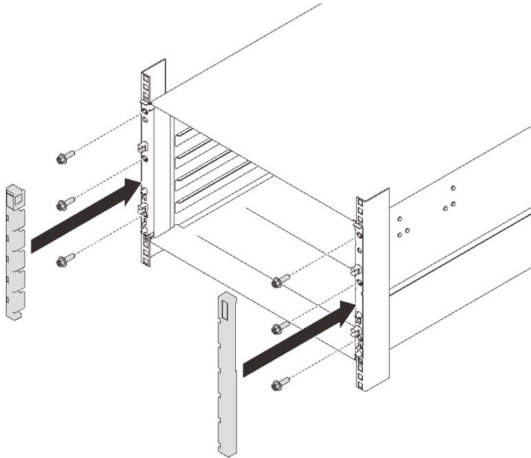
**그림 41. EIA 덮개 설치**
