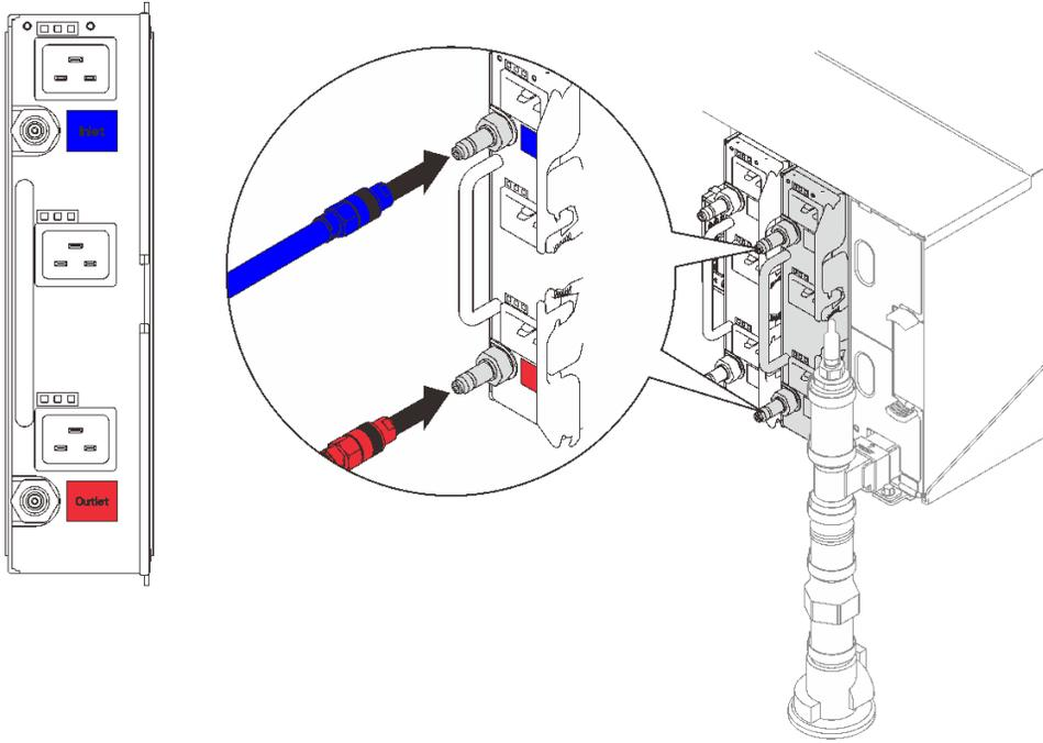
**그림 70. DWC PSU 호스 어셈블리 설치**
