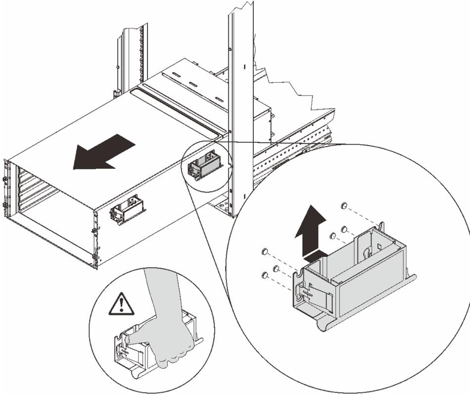
**그림 35. 뒷면 손잡이 설치**
