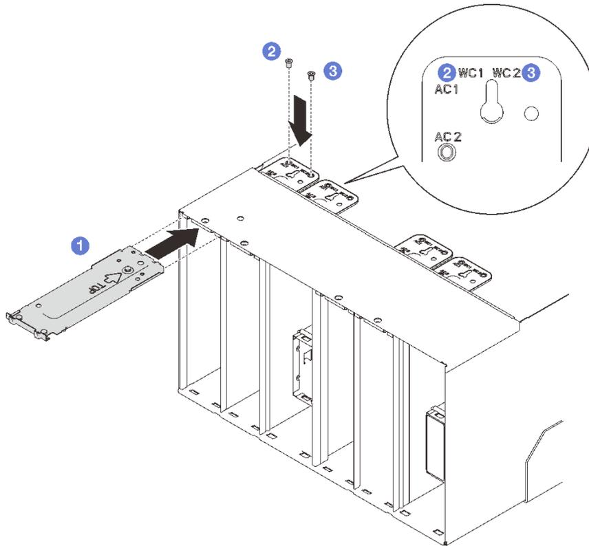
그림 53. DWC PSU 브래킷 설치
