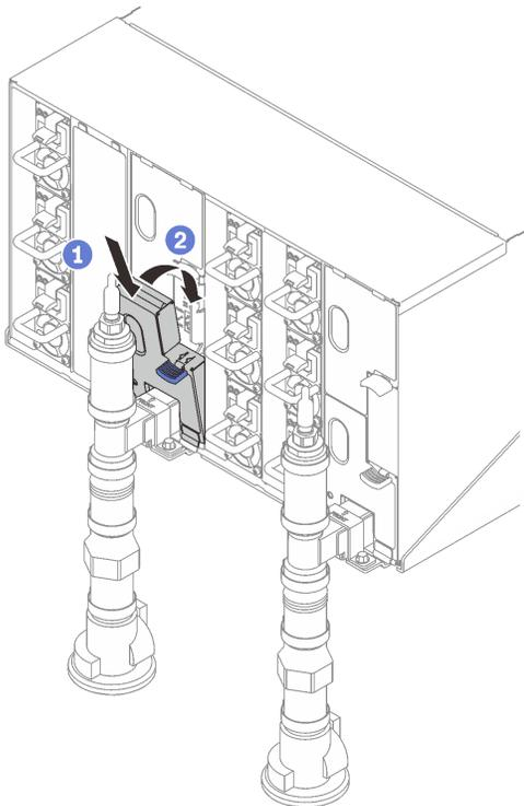
**그림 157. 하단 EMC 실드 설치**
