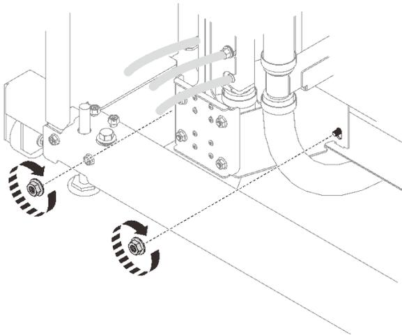
**그림 69. 하단 랙 매니폴드 마운팅 브래킷 너트 설치**
