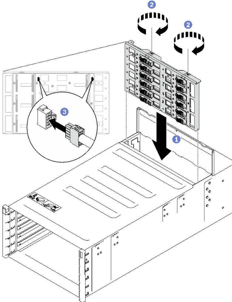
**그림 95. 엔클로저 미드프레인 설치**
