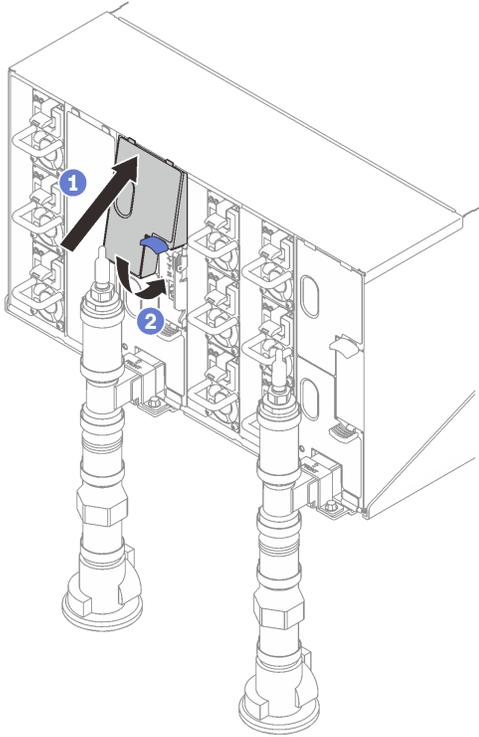
**그림 156. 상단 EMC 실드 설치**
