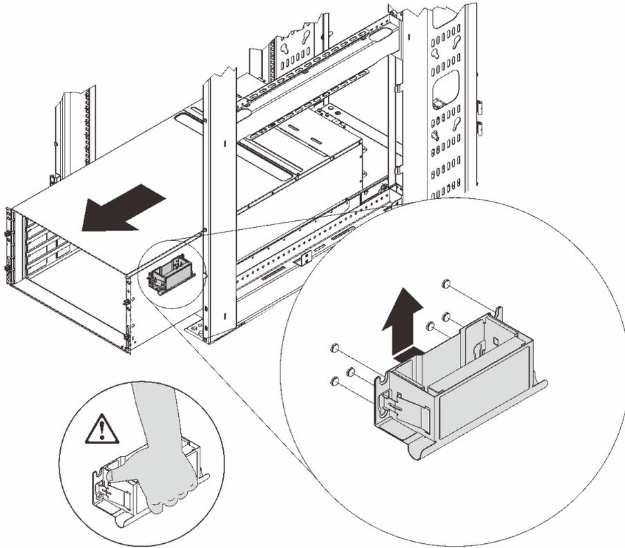
**그림 34. 앞면 손잡이 설치**
