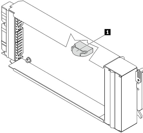
그림 130. SMM2 배터리 위치
