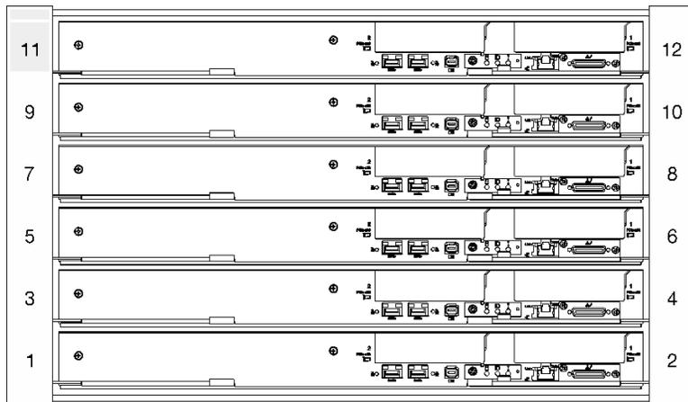
**그림 7. SD650-I V3 서버 6개가 설치된 DW612S 엔클로저**
