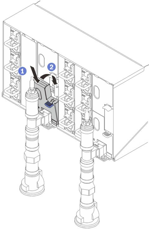
그림 91. 하단 EMC 실드 설치
