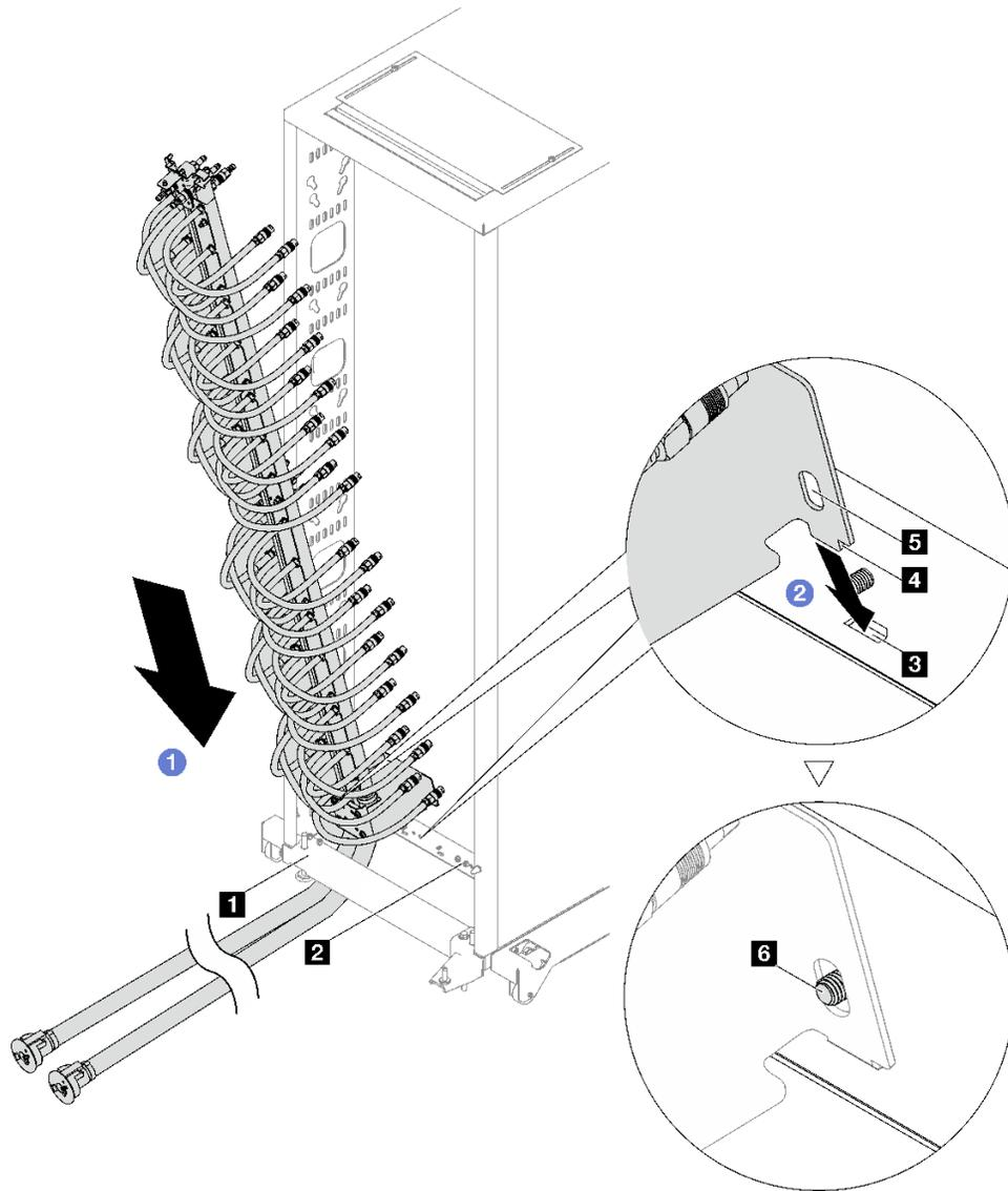
**그림 67. DWC PSU 매니폴드 어셈블리 설치**
