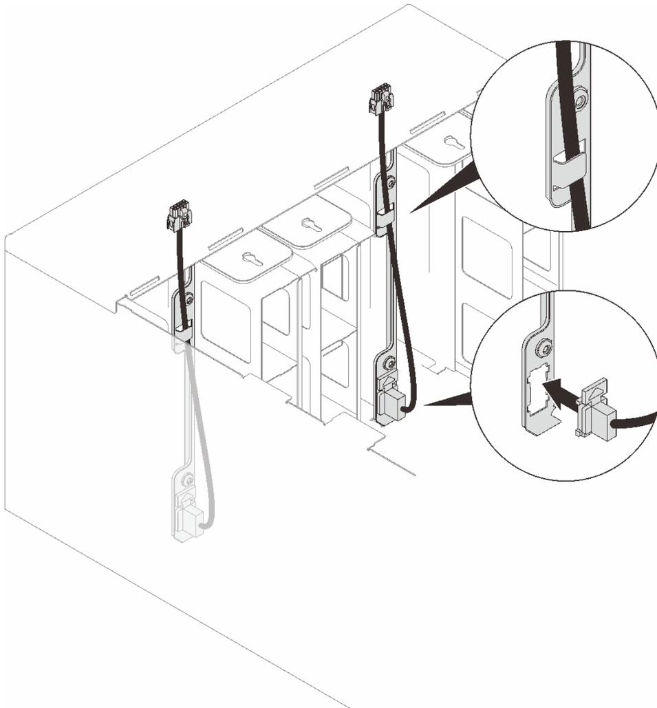
그림 94. 드립 센서 케이블 설치
