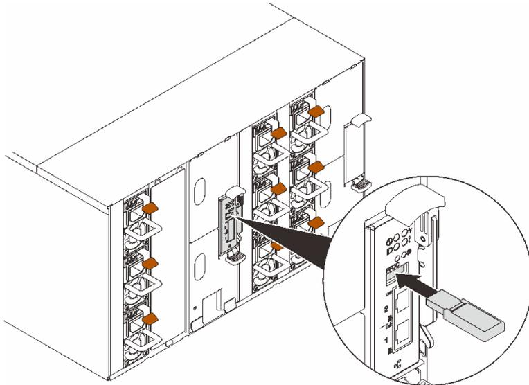
**그림 134. USB 플래시 드라이브 설치**
