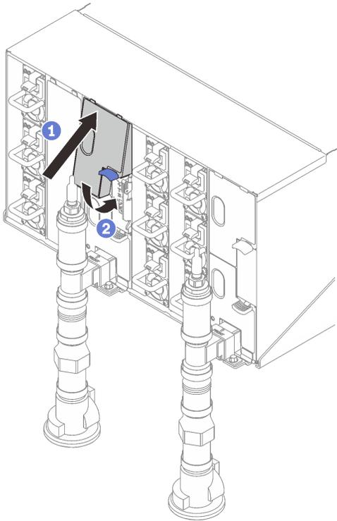
**그림 90. 상단 EMC 실드 설치**
