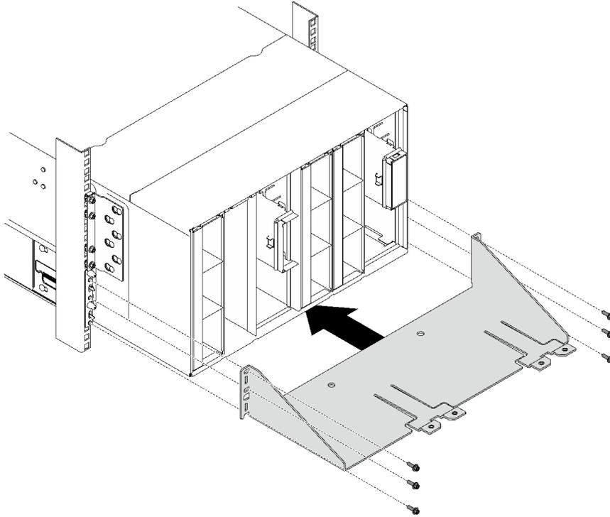
그림 43. 운반 브래킷 설치
