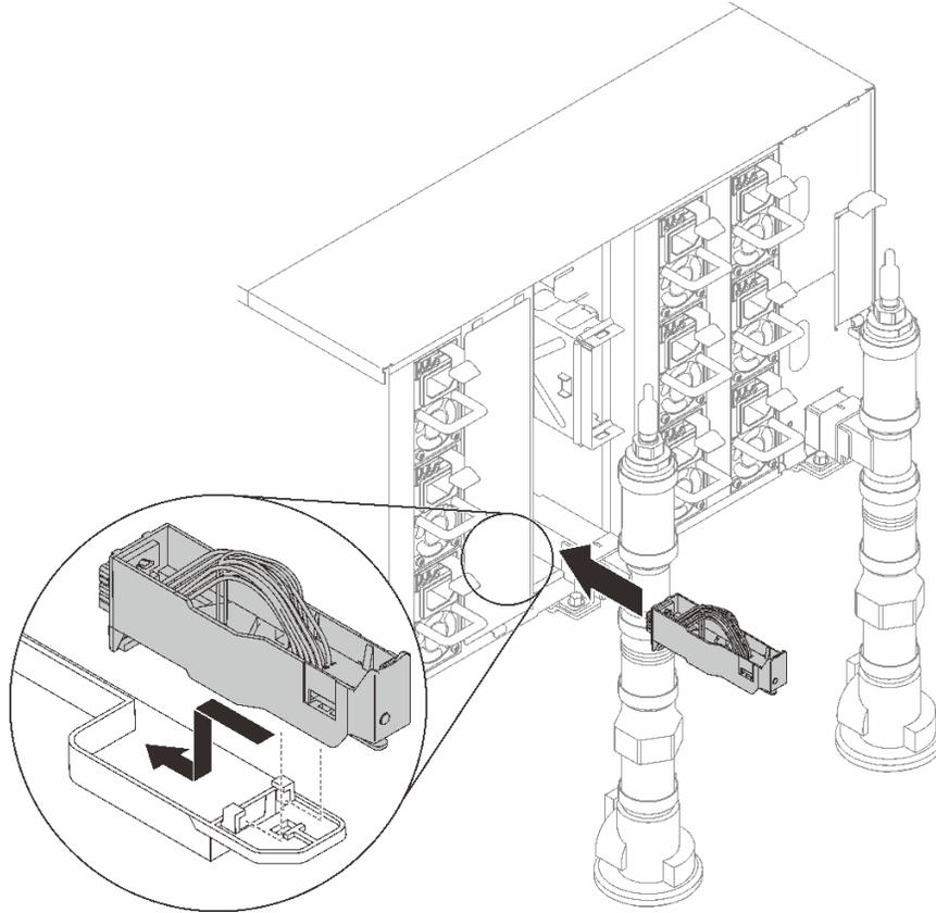
그림 48. 드립 센서 어셈블리 설치
