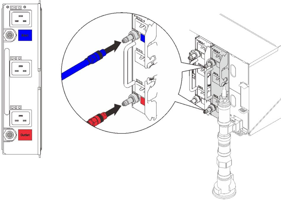
**그림 85. DWC PSU 호스 어셈블리 설치**
