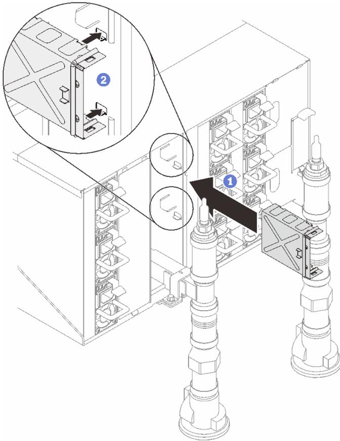
**그림 141. 지지 브래킷 설치**
