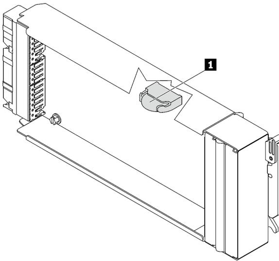
그림 132. SMM2 배터리 위치
