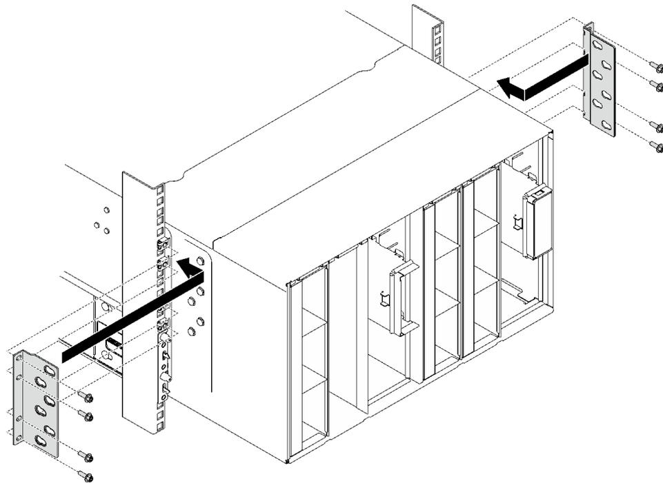
**그림 42. 지지 브래킷 설치**
