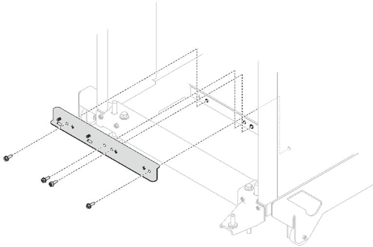
**그림 65. 하단 랙 매니폴드 마운팅 브래킷 설치**
