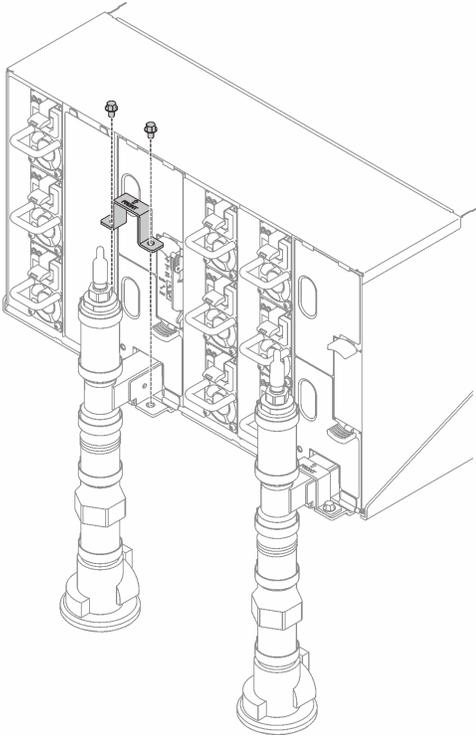
**그림 115. 고정 브래킷 설치**
