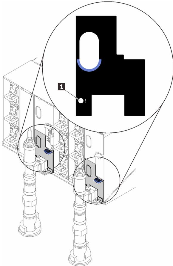
그림 152. 드립 센서 LED
