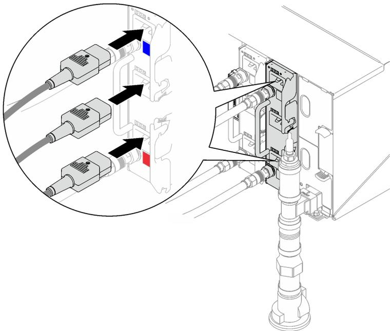
**그림 86. DWC PSU 전원 코드 설치**
