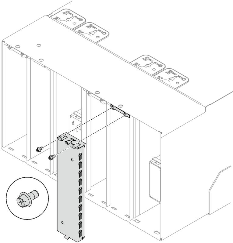
그림 79. DWC PSU 필터 설치
