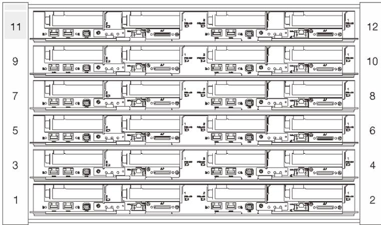
**그림 144. 6개의 SD650 V3 트레이가 설치된 DW612S 엔클로저의 앞면 보기**
