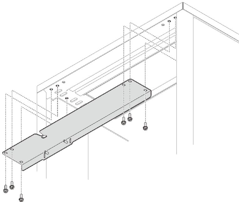
**그림 66. 상단 랙 매니폴드 마운팅 브래킷 설치**
