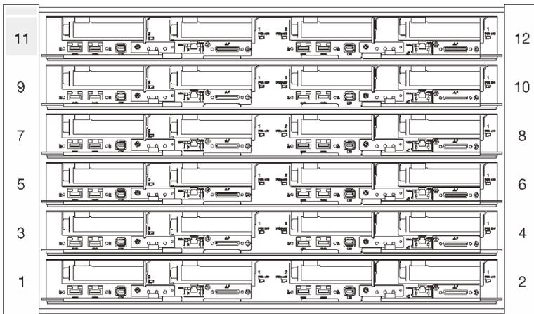
그림 6. SD650 V3 서버 6개가 설치된 DW612S 엔클로저
