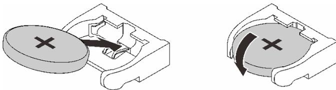
그림 133. SMM2 배터리 설치
