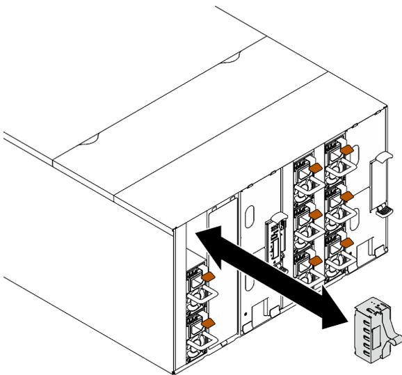
그림 129. PSU 필터 설치
