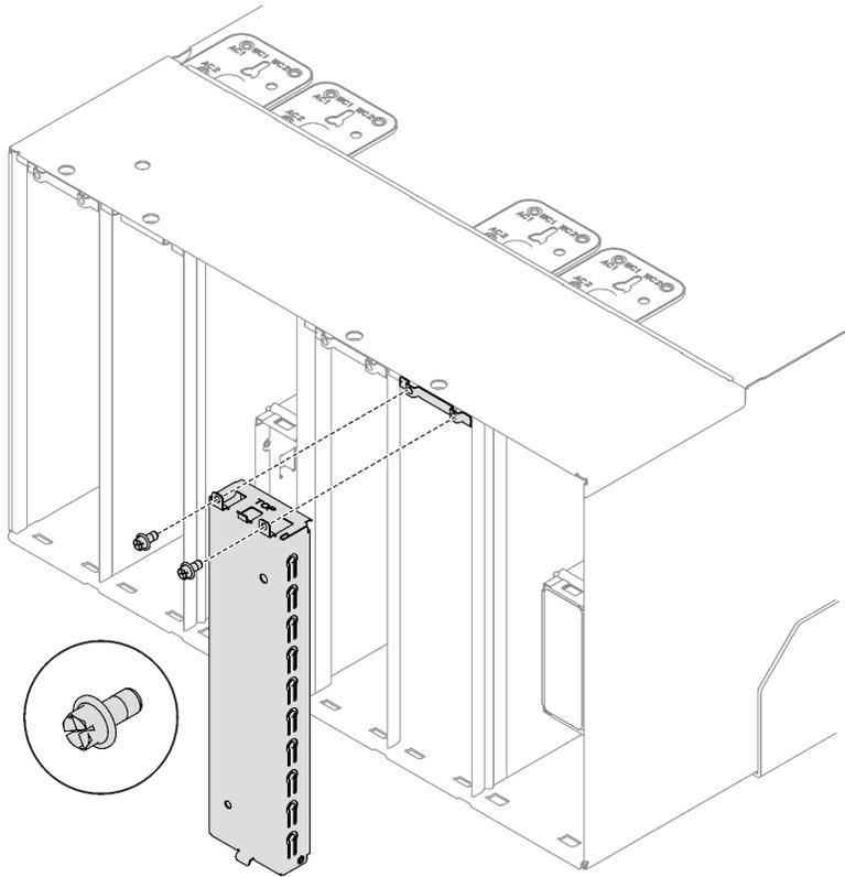
**그림 50. DWC PSU 필러 설치**
