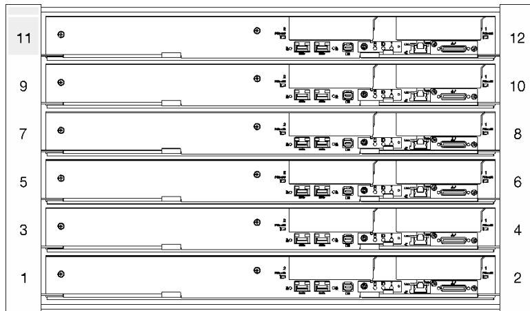
그림 7. SD650-I V3 서버 6개가 설치된 DW612S 엔클로저
