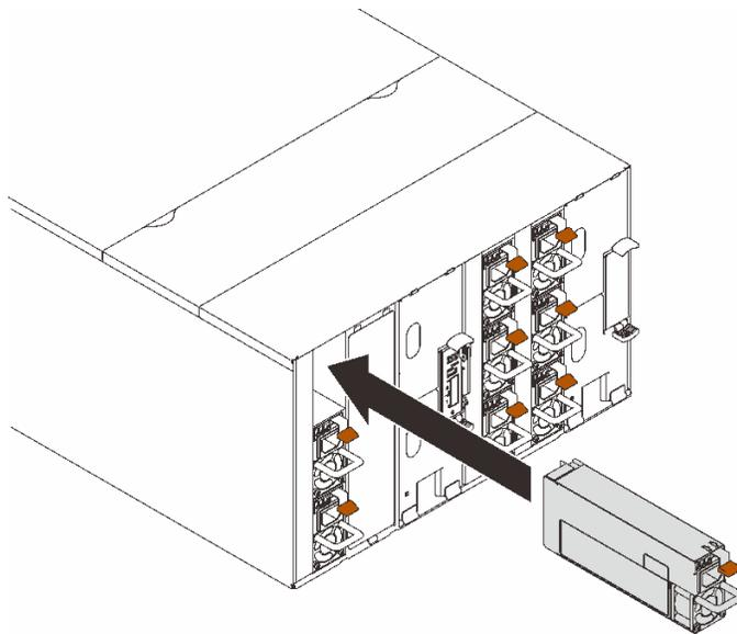
**그림 100. 핫 스왑 전원 공급 장치 설치**
