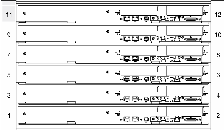
图 12. 配备六个 SD650-I V3 托盘的机柜
