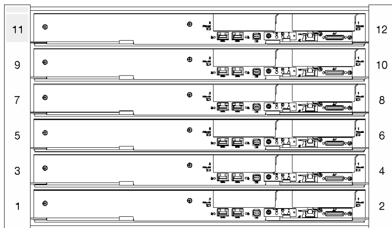
图 7. 装有六台 SD650-I V3 服务器的 DW612S 机柜
