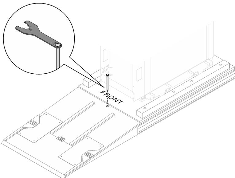
Abbildung 10. Befestigen der Rampe an der Palette
