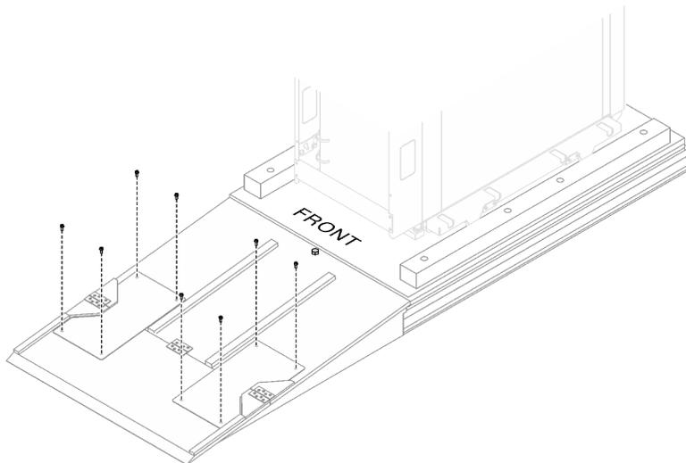
Abbildung 9. Befestigen der beiden Platten an der Rampe
