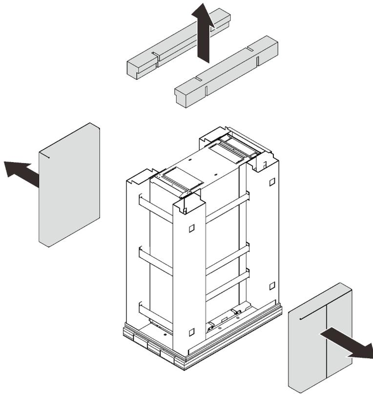
*Abbildung 4. Entfernen der oberen Stangen und seitlichen Kartons*
