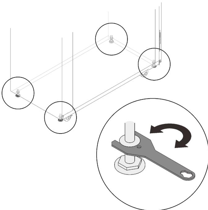
Abbildung 8. Anheben der Ausgleichsunterlagen
