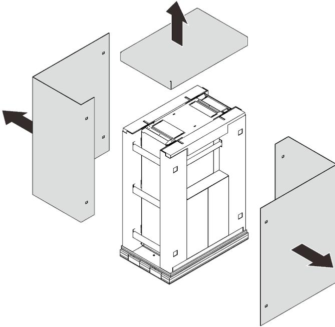
Abbildung 3. Entfernen der Kartons
