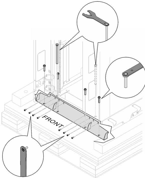
Abbildung 6. Entfernen der vorderen Transporthalterung
