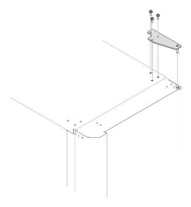
Figure 26. Installing the top hinge
