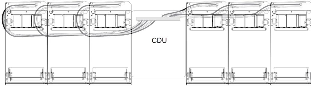
**그림 42. 이중 바닥 및 비이중 바닥 환경의 호스 배선 및 고정(위에서 내려다본 모습)**
