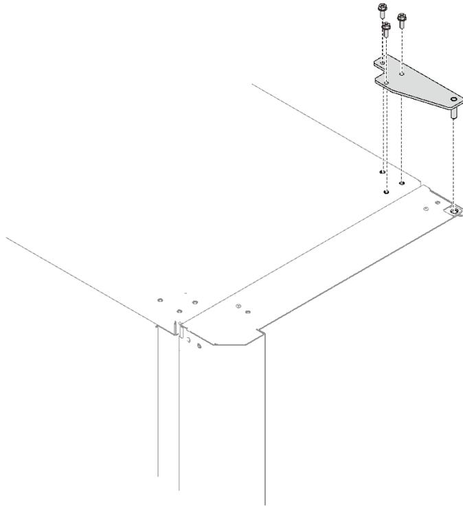
그림 26. 상단 힌지 설치
