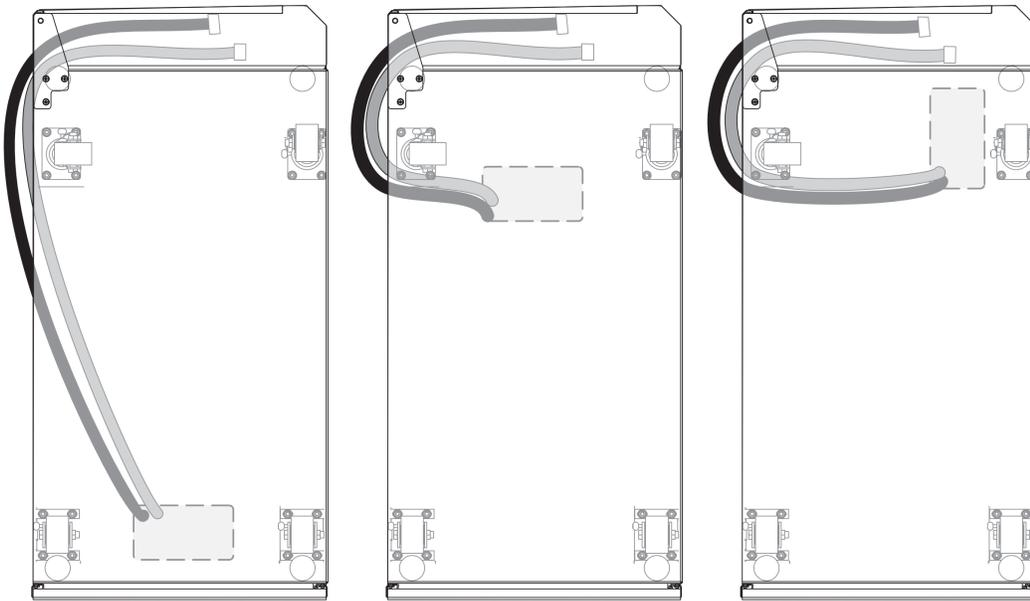
**그림 40. 이중 바닥 환경에서 개별 랙의 호스 배선 및 고정(위에서 내려다본 모습)**
