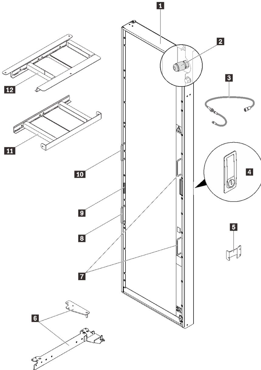
그림 1. ThinkSystem Rear Door Heat eXchanger(48U 랙용) 구성 요소
