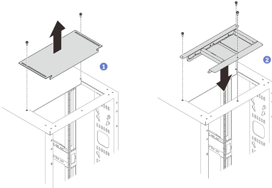
**그림 14. 상부 공기 조절 장치 설치**
