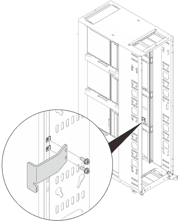
**그림 18. 래치 플레이트 설치**
