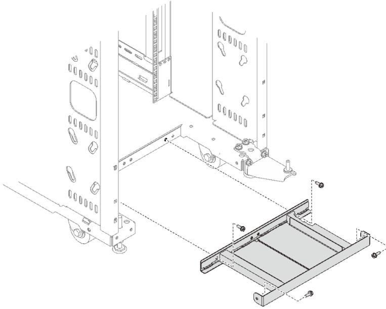
**그림 16. 하부 공기 조절 장치 설치**
