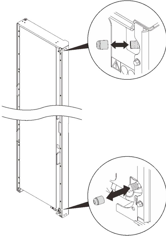
그림 52. 밸브 캡 설치
