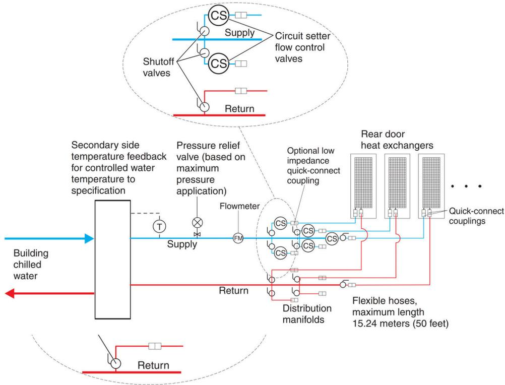
**그림 29. 규격형 공급업체 솔루션을 사용하는 냉각수 분배 장치**
