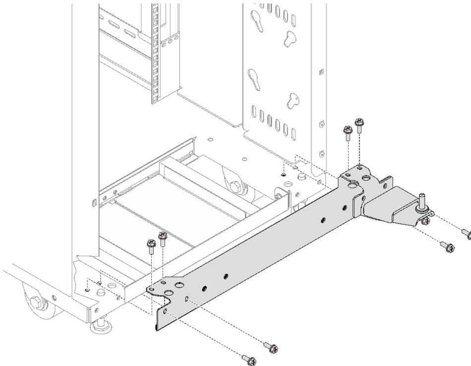
**그림 17. 하단 힌지 어셈블리 설치**
