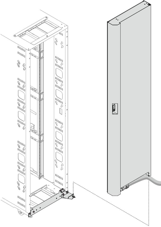
**그림 25. 랙 캐비닛에 열교환기 설치**
