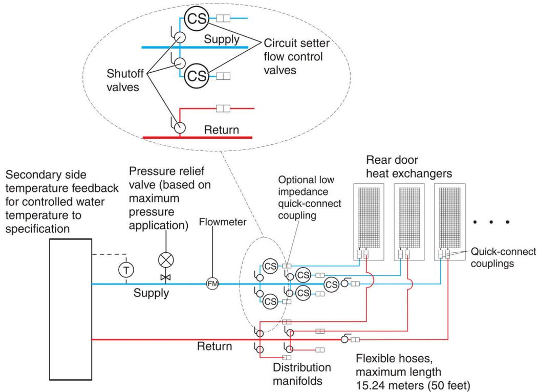
**그림 30. 규격형 공급업체 솔루션을 사용하는 냉각수 분배 장치**
