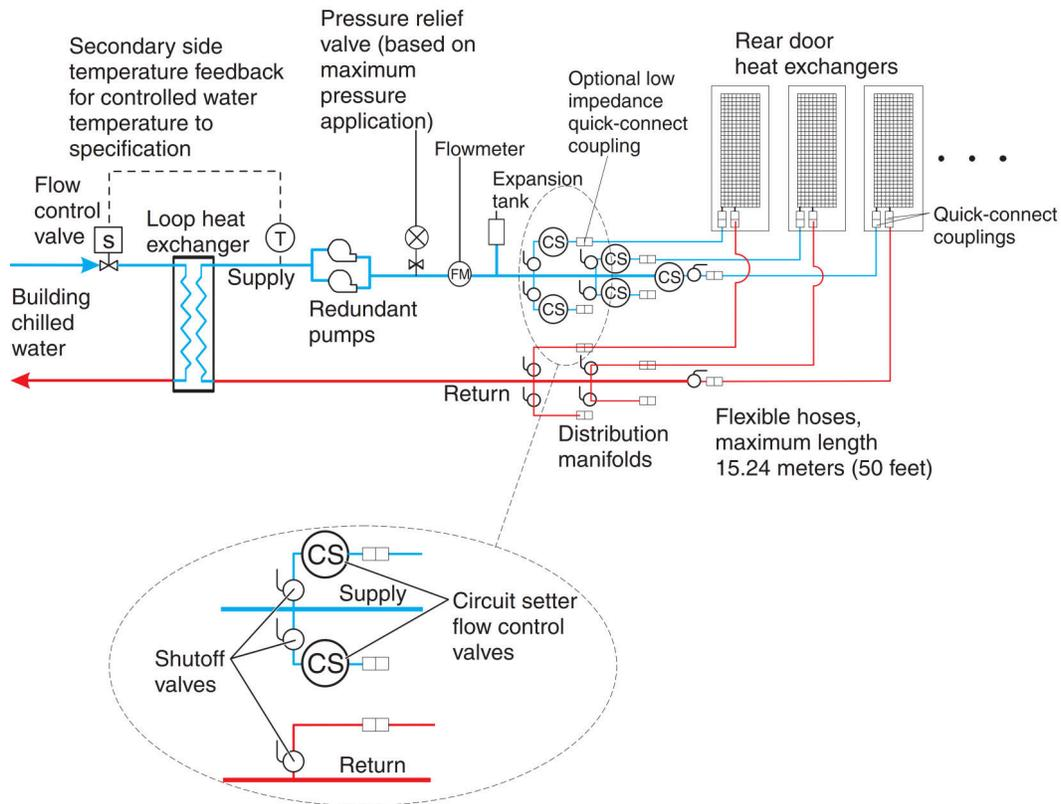
**그림 28. 제작형 설비 솔루션을 사용하는 냉각수 분배 장치**
