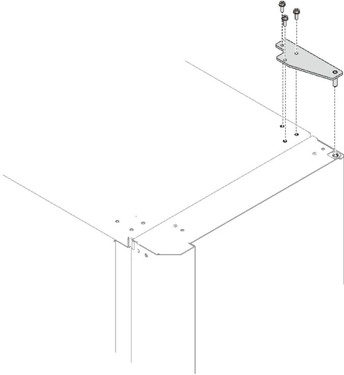
그림 63. 상단 힌지 설치
