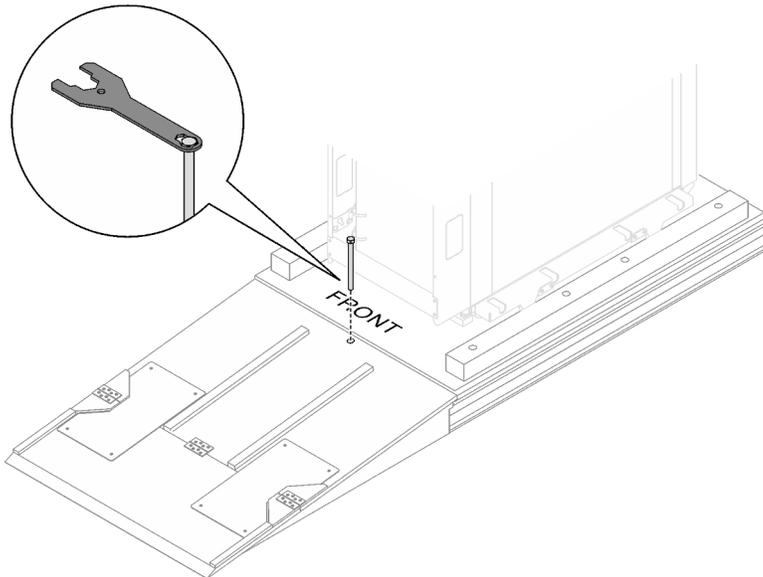
Figura 10. Fixando a rampa ao palete
