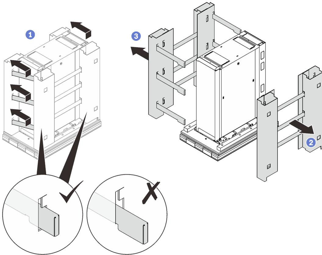
Figura 5. Removendo as estruturas laterais
