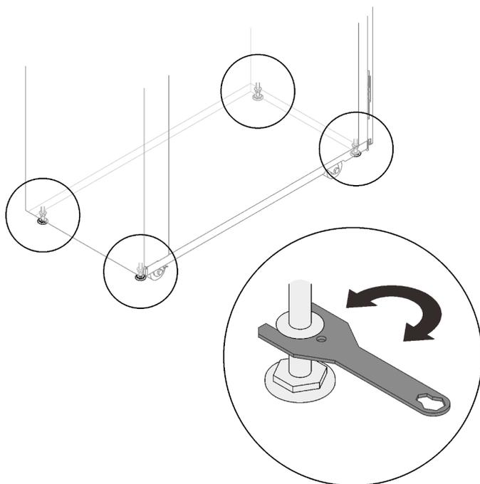
*Figura 8. Levantando os pés de nivelamento*
