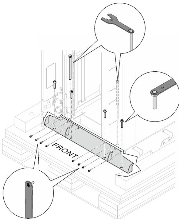
Figura 6. Removendo o suporte de remessa frontal
