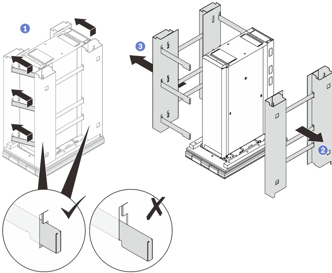
Figura 5. Removendo as estruturas laterais
