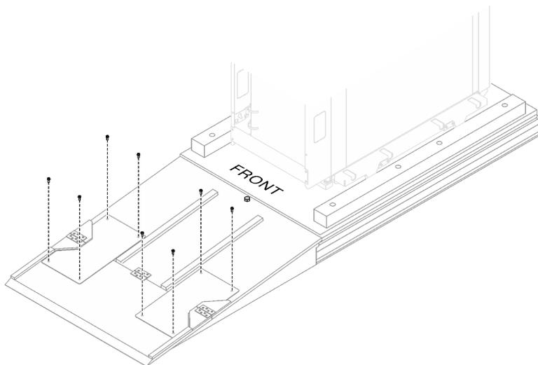
Figura 9. Fixando as duas placas na rampa
