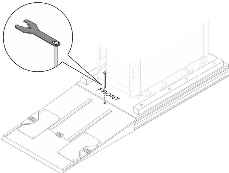
Figura 10. Fixando a rampa ao palete
