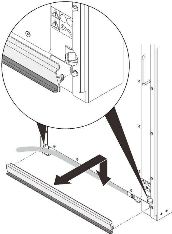
Рис. 111. Установка внутренней панели доступа к шлангам
