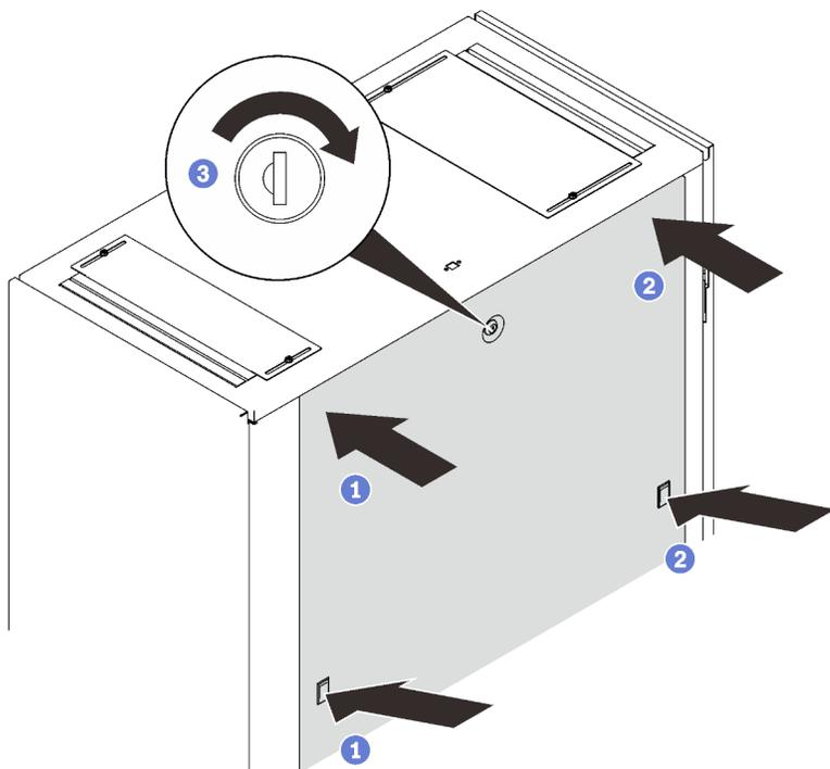
Рис. 129. Фиксация бокового кожуха
