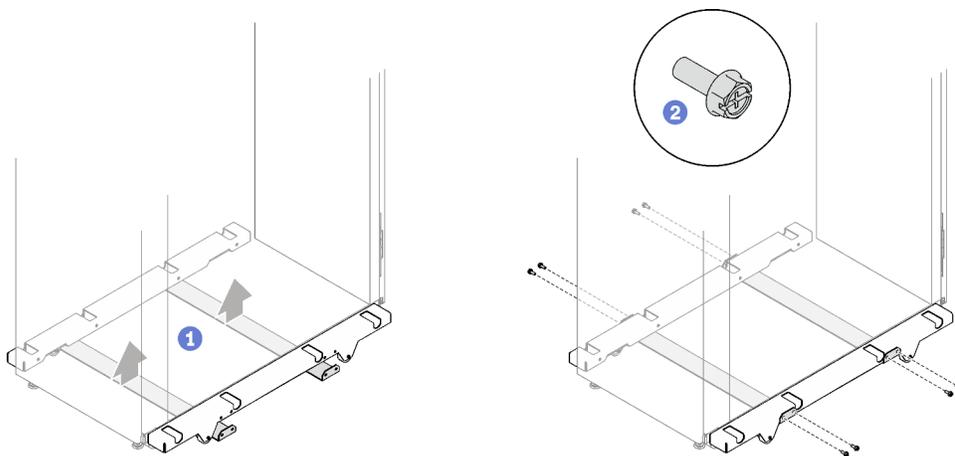
Рис. 194. Установка стабилизирующих планок выносных опор
