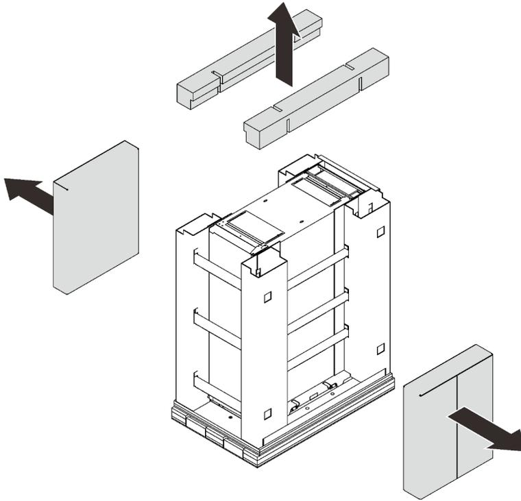
*Рис. 17. Снятие верхних планок и боковых бортов*
