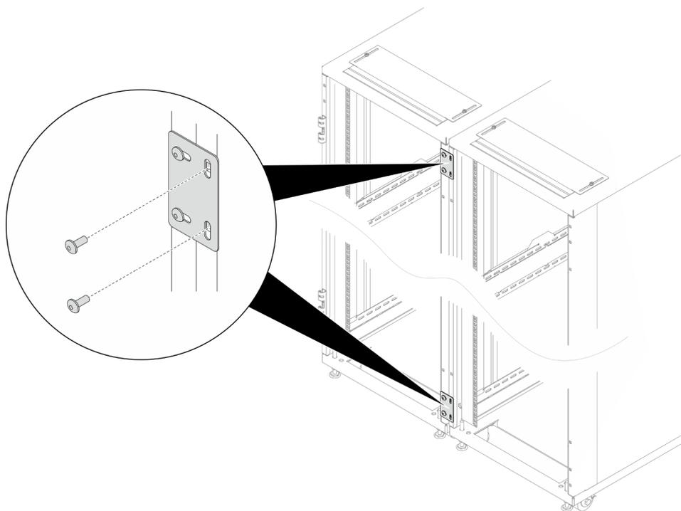
Рис. 32. Снятие винтов для подготовки к установке комплекта расширения
