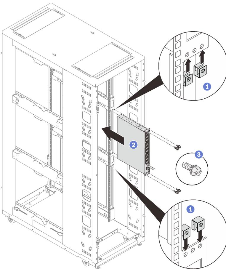
Рис. 187. Установка 1U PDU или консольного коммутатора
