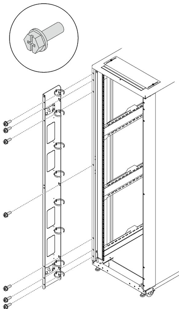
Рис. 179. Установка панели расширения
