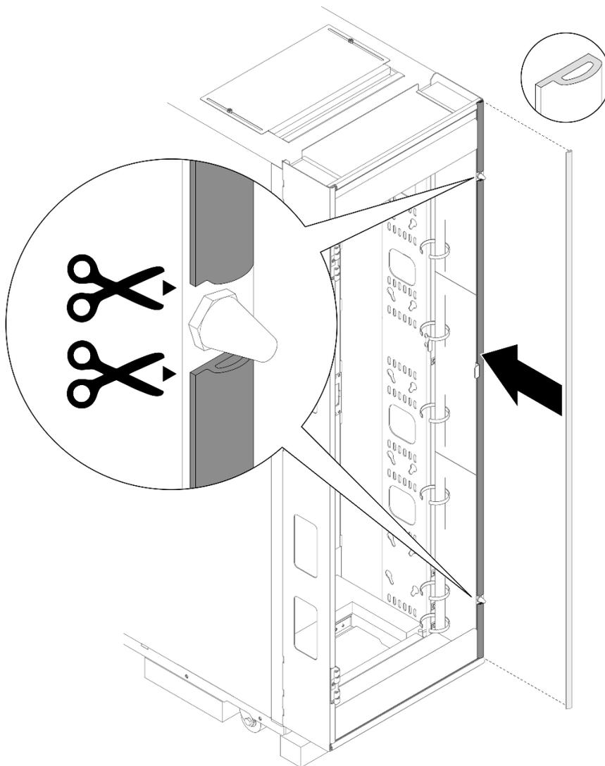
Рис. 72. Установка поролона для герметизации комплекта расширения с правой стороны стойки
