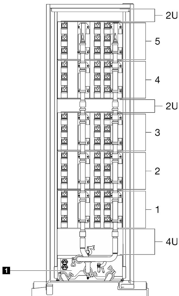
Рис. 5. Схема распределения охлаждающей жидкости внутри стойки — вид сзади
