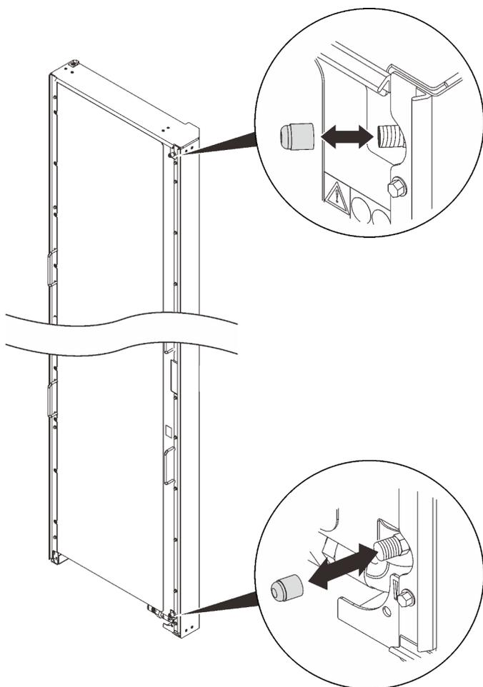
Рис. 142. Снятие колпачков клапанов
