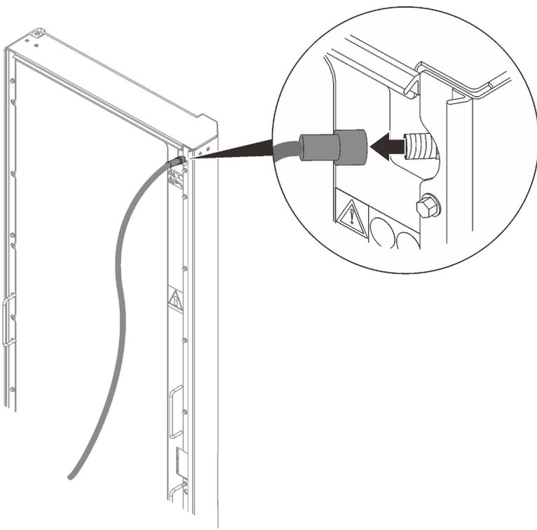
Рис. 109. Снятие инструмента для удаления воздуха
