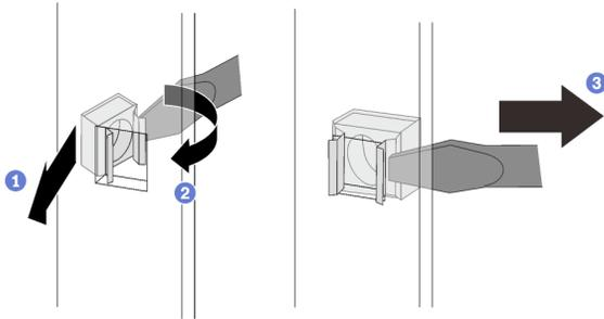
Рис. 55. Установка закладных гаек с помощью шлицевой отвертки
