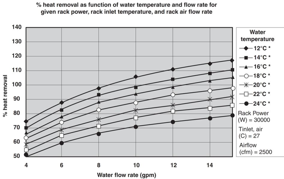
Рис. 11. Типичная производительность теплообменника, тепловая нагрузка 30 кВт
