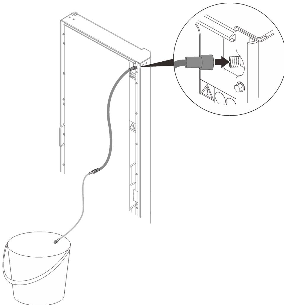
Рис. 163. Установка инструмента для удаления воздуха
