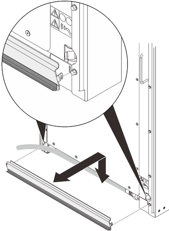
Рис. 139. Снятие внутренней панели доступа к шлангам
