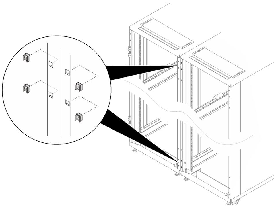
Рис. 30. Установка закладных гаек
