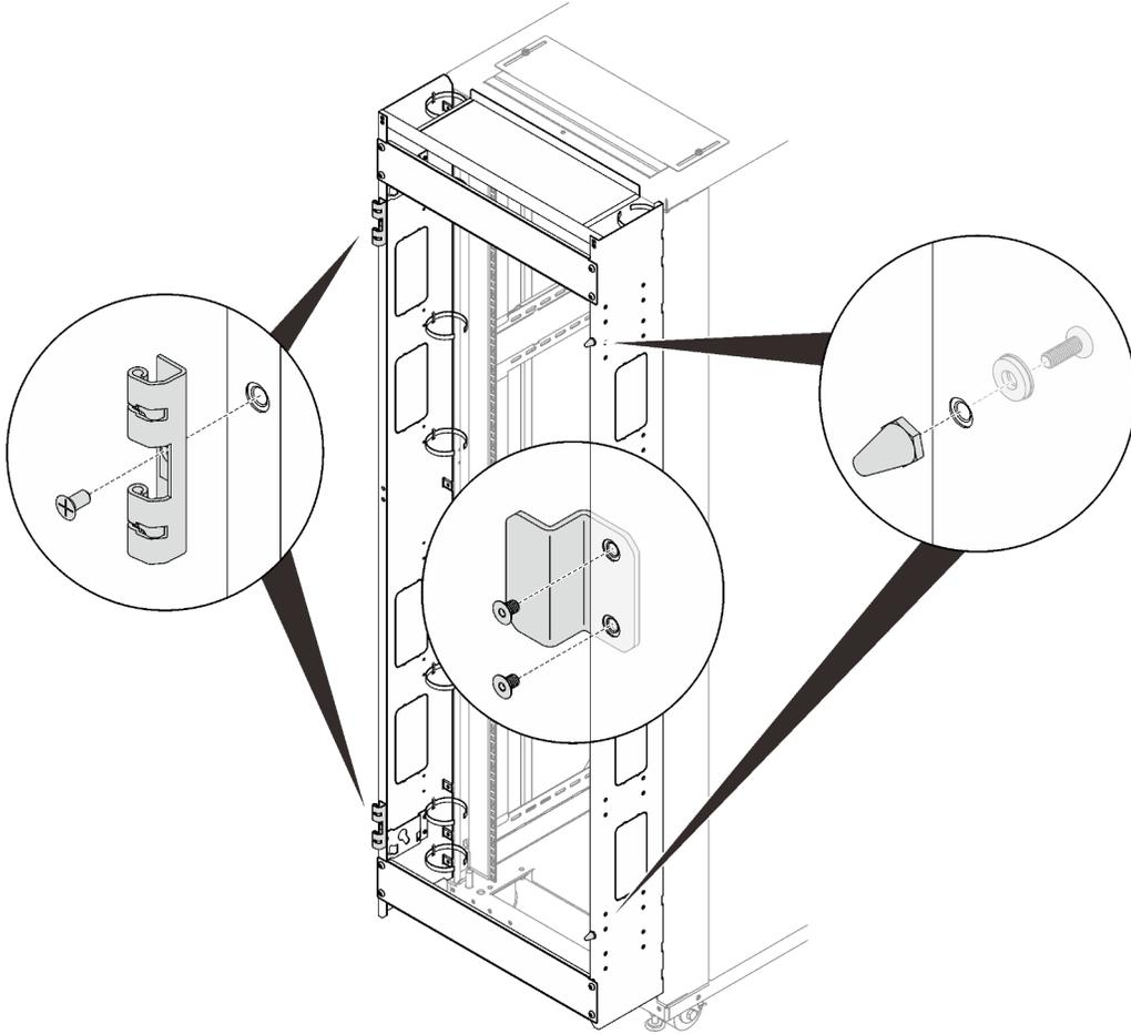
*Рис. 45. Установка петель, дверных ограничителей и дверной защелки*
