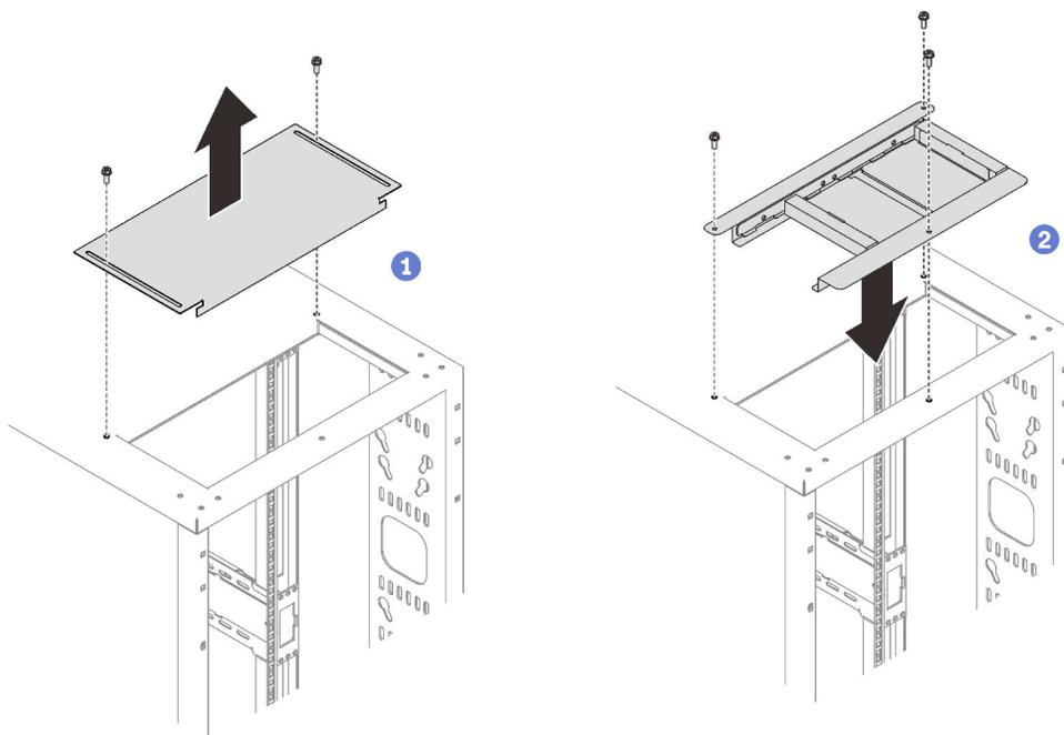
Рис. 89. Установка верхнего дефлектора
