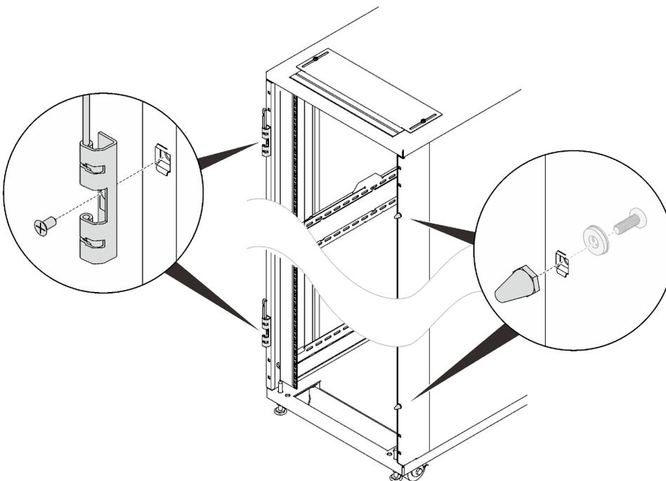
Рис. 181. Установка петель и дверных ограничителей
