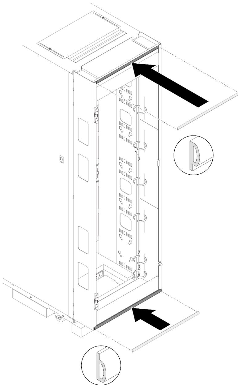
Рис. 73. Установка поролона для герметизации комплекта расширения на верхний и нижний кожухи комплекта расширения
