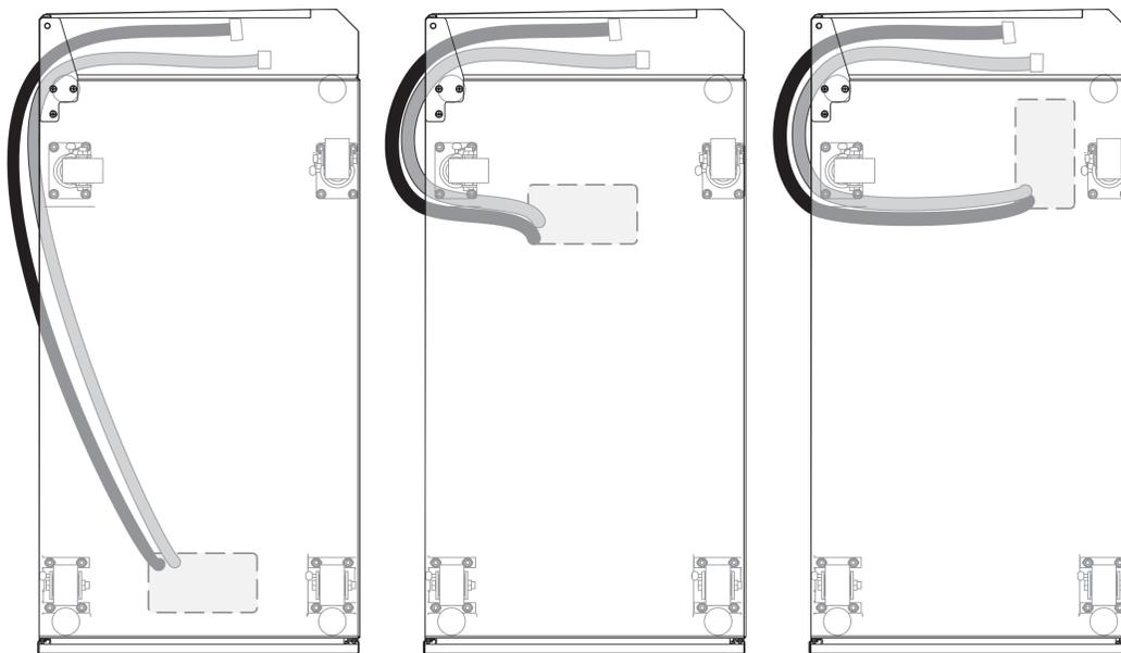
Рис. 124. Прокладка и фиксация шлангов в помещении с фальшполом для отдельно стоящих стоек (вид сверху, если смотреть вниз)
