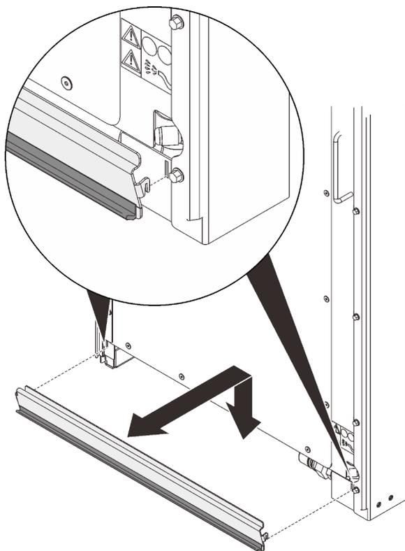
Рис. 104. Снятие внутренней панели доступа к шлангам
