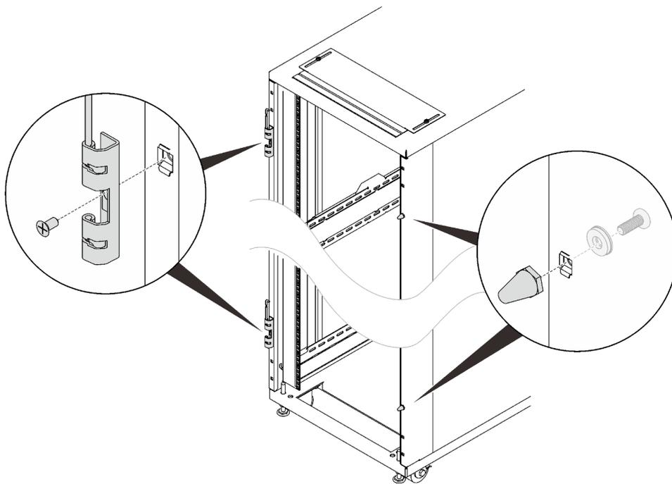
Рис. 51. Снятие дверных петель и нижних кожухов комплекта расширения
