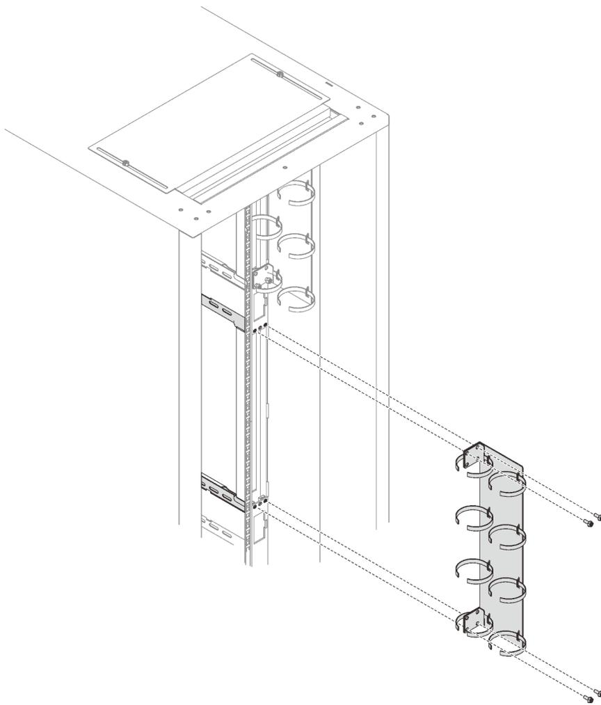
Рис. 197. Снятие задней скобы кабельного органайзера
