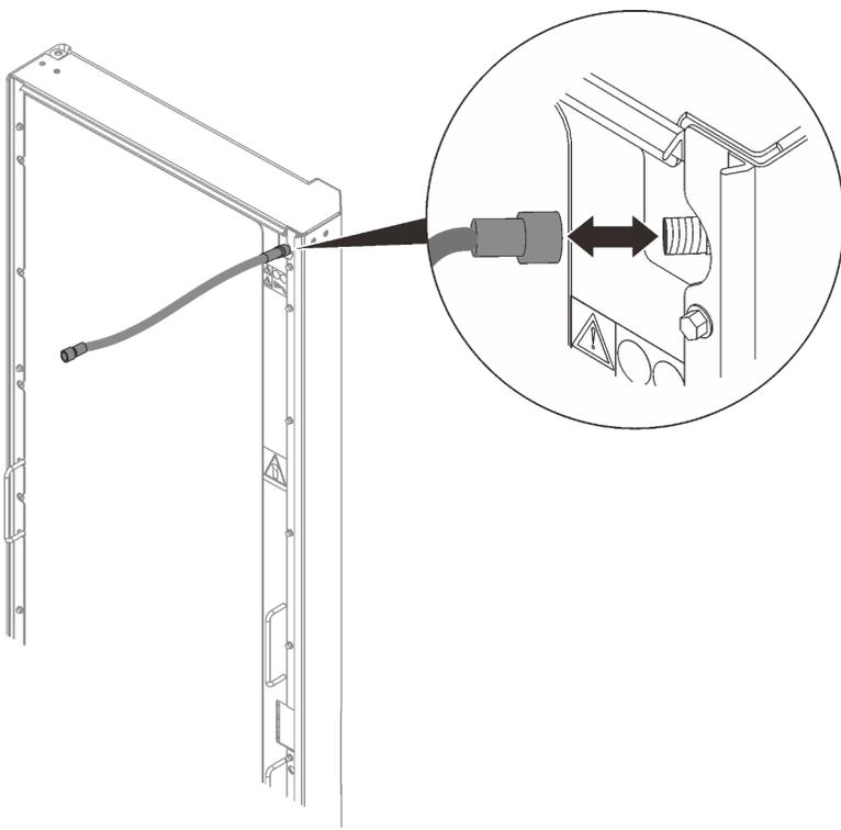
Рис. 146. Снятие удлинительного шланга инструмента для удаления воздуха
