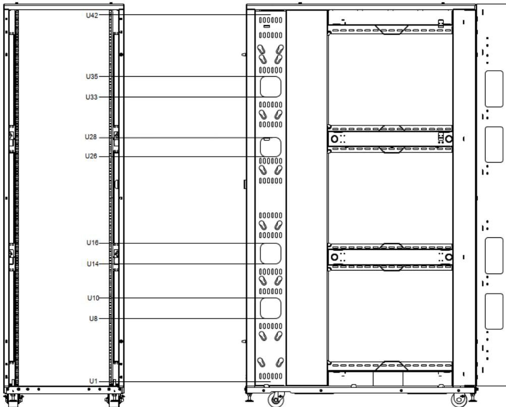
Рис. 119. Отверстия для доступа к кабелям с задней стороны стойки
