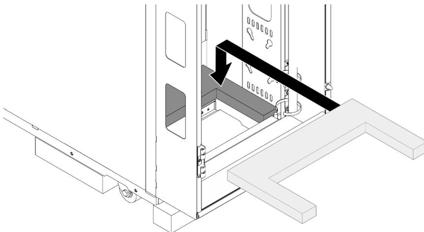
Рис. 66. Установка поролона для задней стороны стойки
