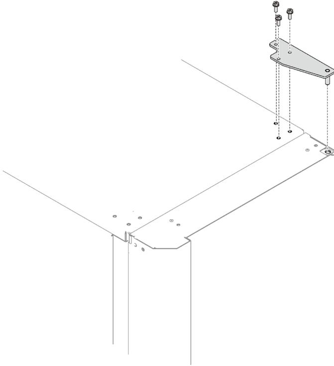
Рис. 157. Установка верхней петли
