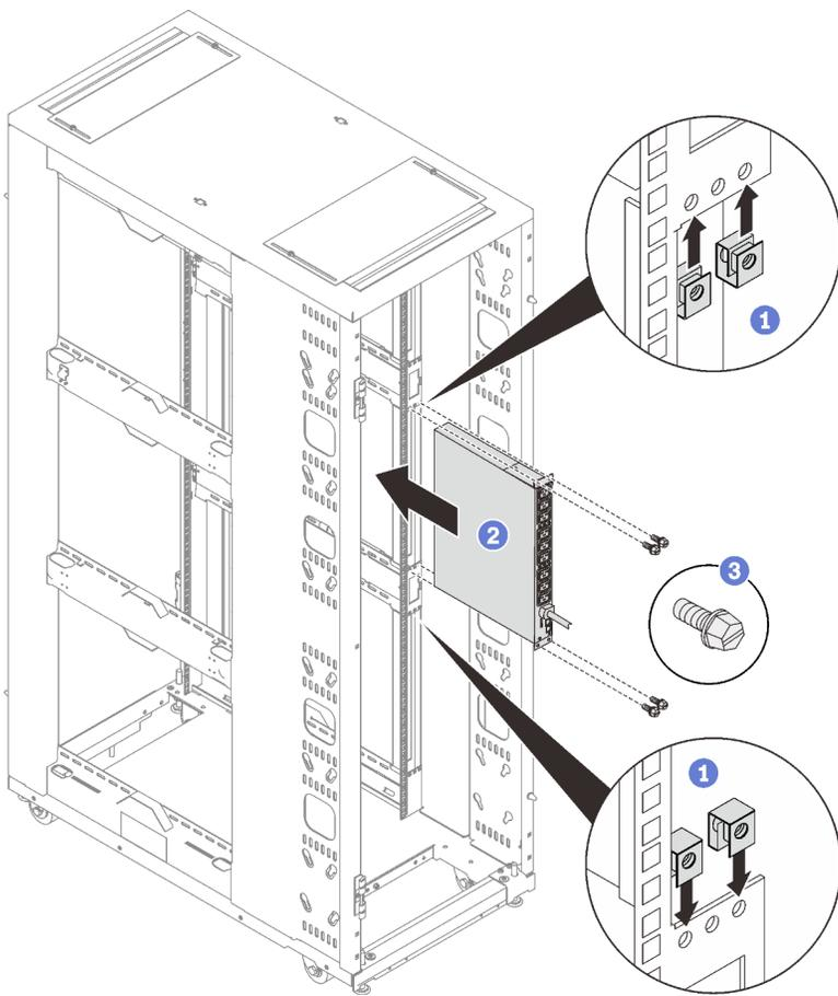
Рис. 115. Установка 1U PDU или консольного коммутатора
