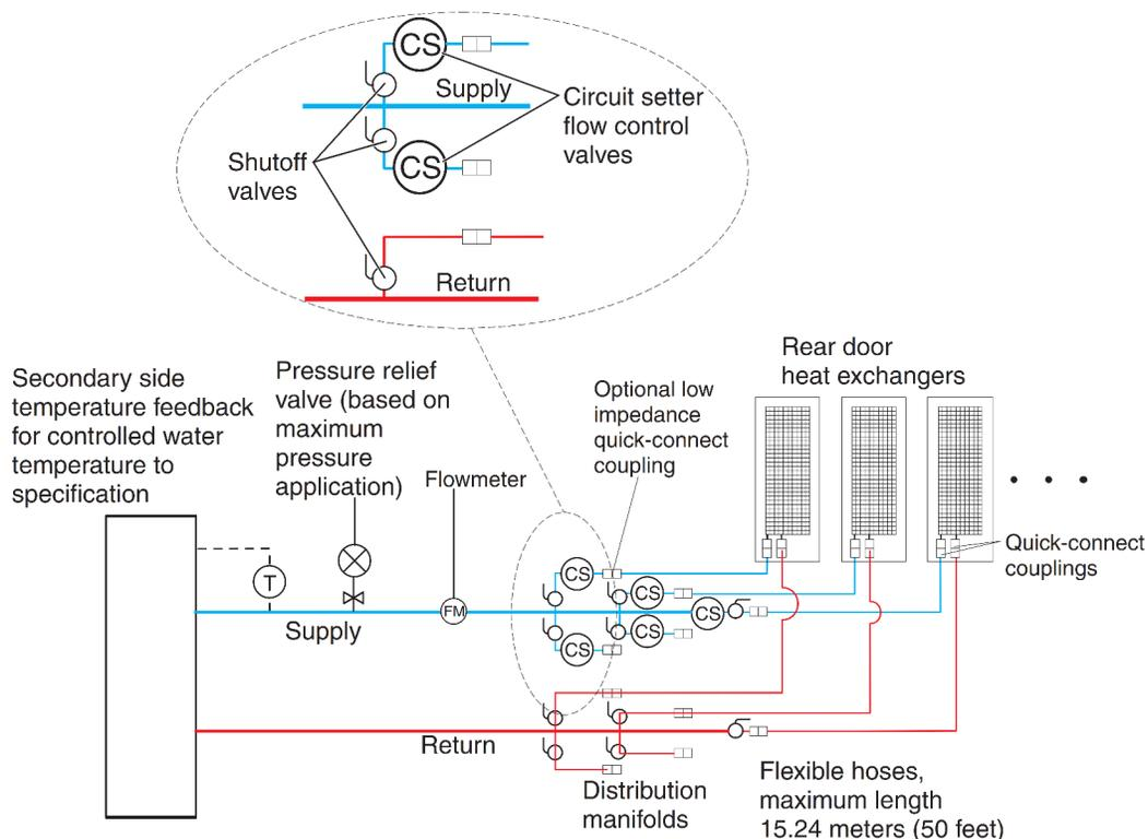
Рис. 101. Блок распределения охлаждающей жидкости с готовыми решениями от поставщиков
