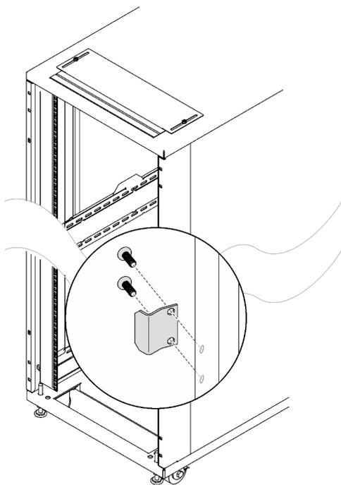
Рис. 52. Снятие дверной защелки
