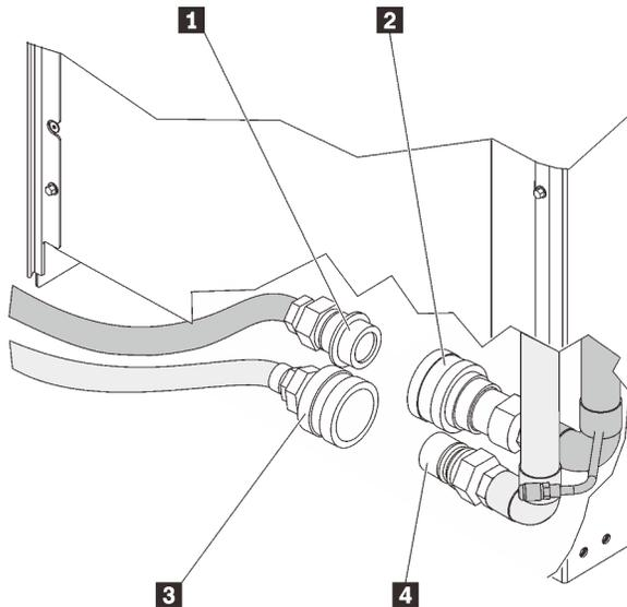
Рис. 162. Подающий и возвратный шланги и муфты коллектора
