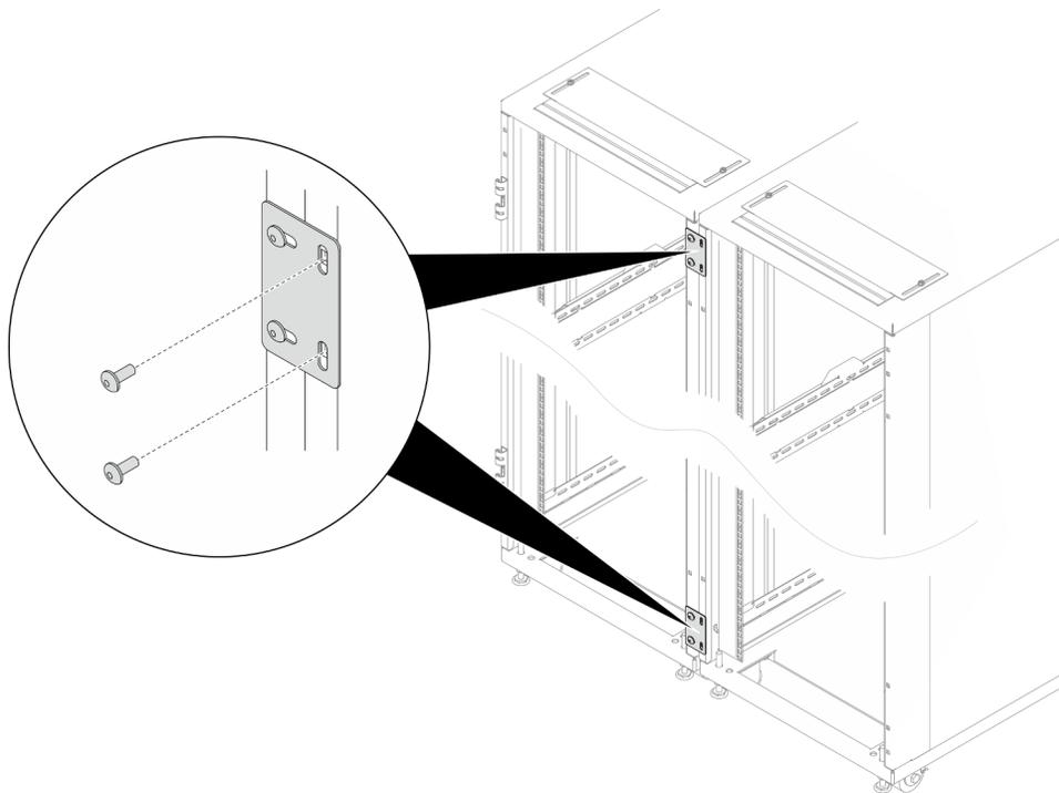
Рис. 47. Снятие винтов для подготовки к установке комплекта расширения
