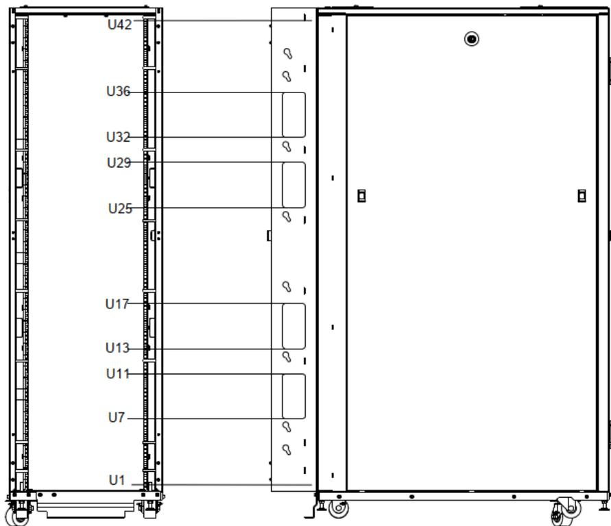
Рис. 7. Отверстия на панели расширения
