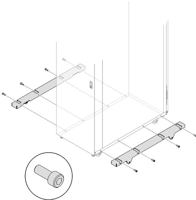
Рис. 191. Снятие выносных опор
