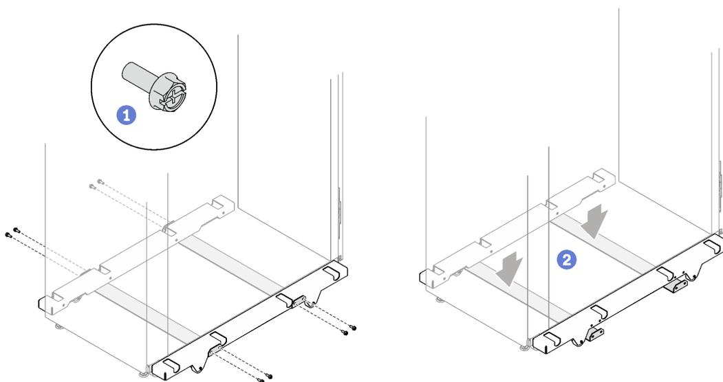
Рис. 190. Снятие стабилизирующих планок выносных опор
