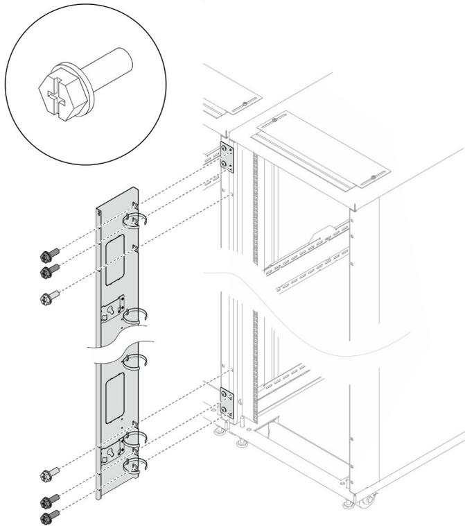
Рис. 171. Установка панели расширения (с комплектом крепления стоек)
