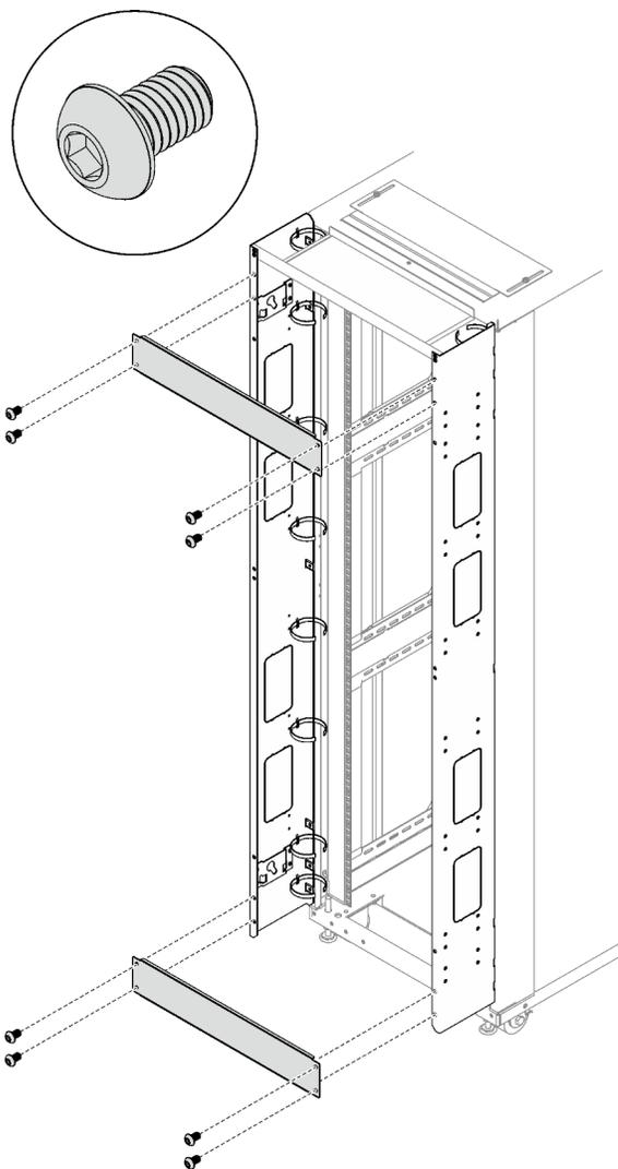
Рис. 44. Установка опорных скоб
