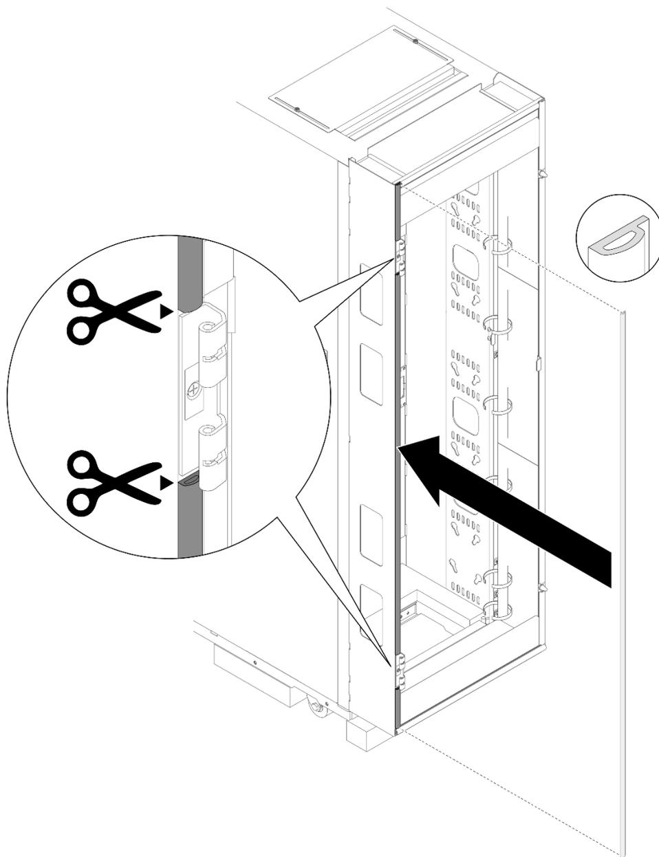
Рис. 71. Установка поролона для герметизации комплекта расширения с левой стороны стойки
