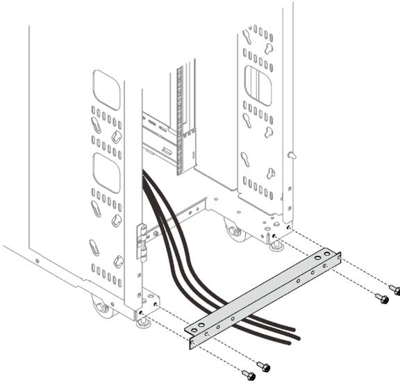
Рис. 90. Снятие панели для доступа к кабелям
