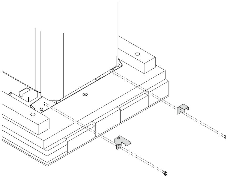
*Рис. 82. Снятие опорных скоб*
