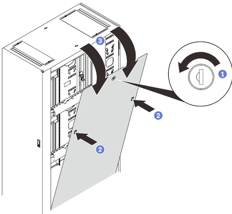
Рис. 29. Снятие бокового кожуха
