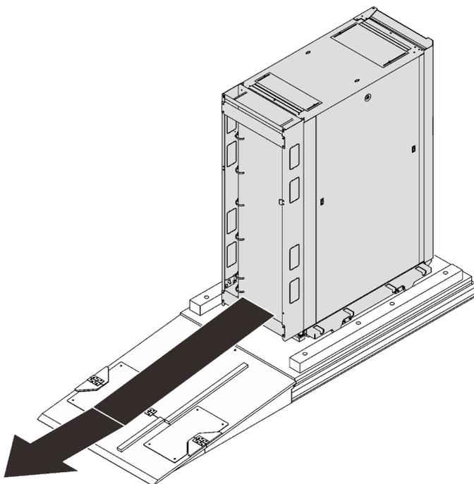
Рис. 83. Перемещение стойки с поддона
