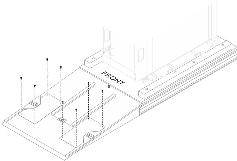
Рис. 22. Фиксация двух пластин на рампе
