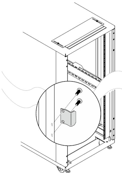
Рис. 87. Снятие дверной защелки
