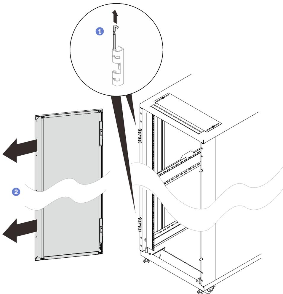
Рис. 38. Снятие дверцы
