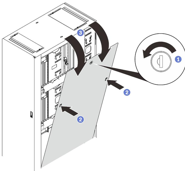
Рис. 127. Снятие бокового кожуха
