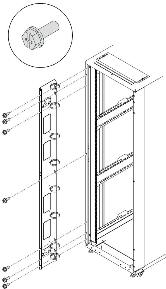
Рис. 170. Установка панели расширения
