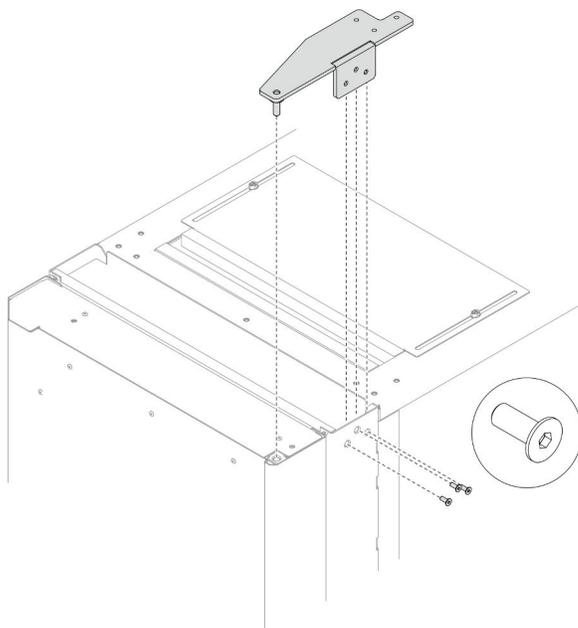
Рис. 64. Установка верхней петли
