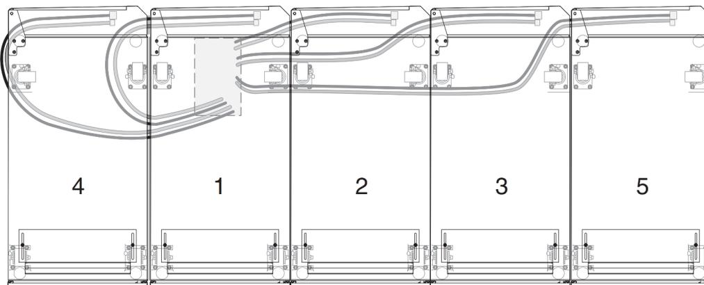
Чтобы проложить и зафиксировать шланги в помещении с фальшполом, выполните следующие действия.
