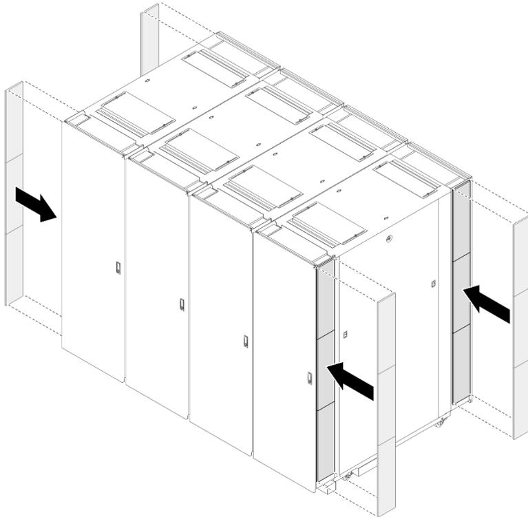
*Рис. 69. Установка поролона для комплекта расширения*
