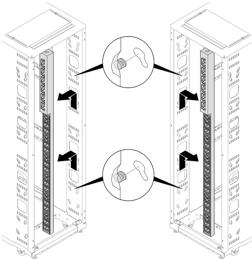
Рис. 184. Снятие 0U PDU
