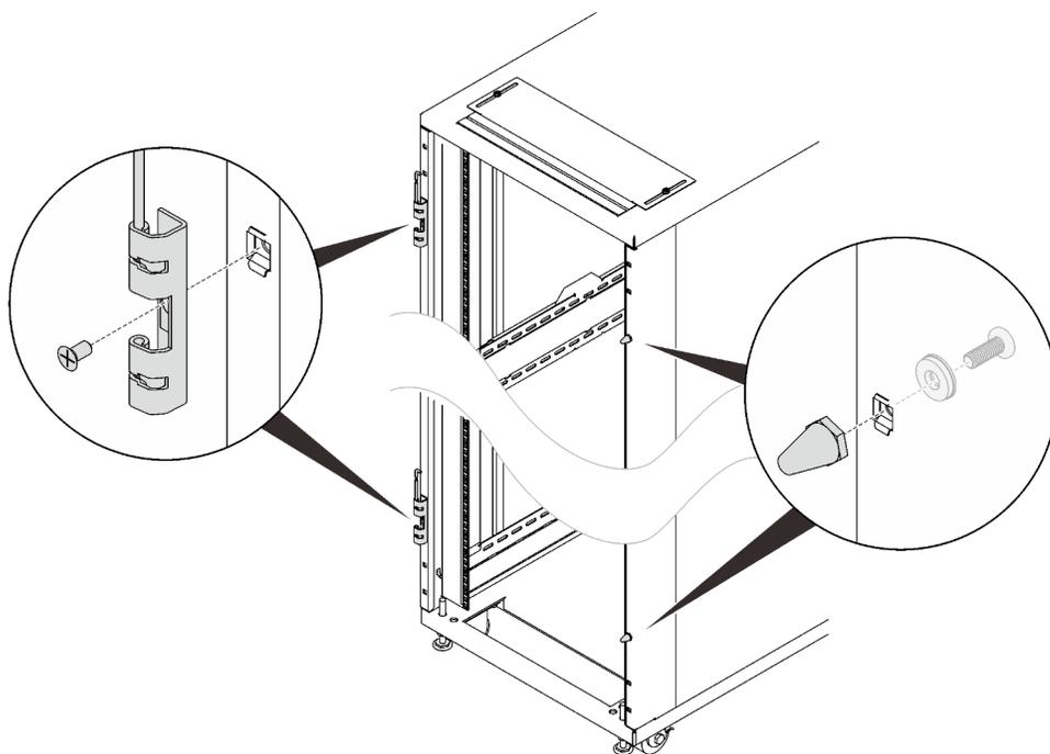
*Рис. 133. Снятие петель и дверных ограничителей*
