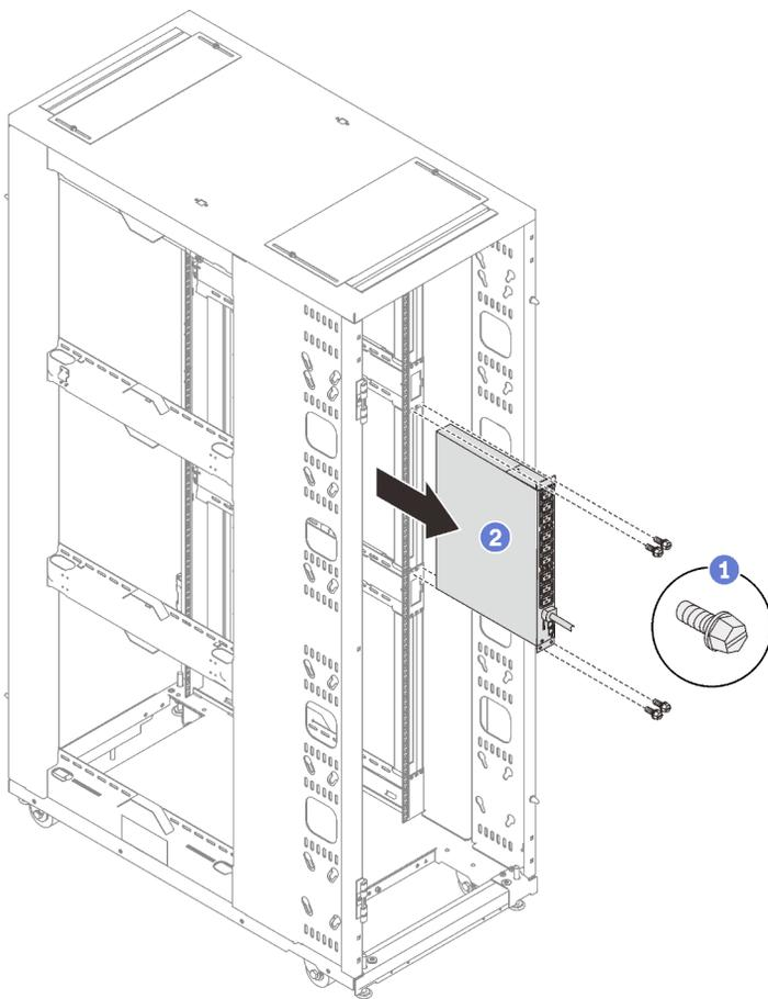
Рис. 188. Снятие 1U PDU или консольного коммутатора
