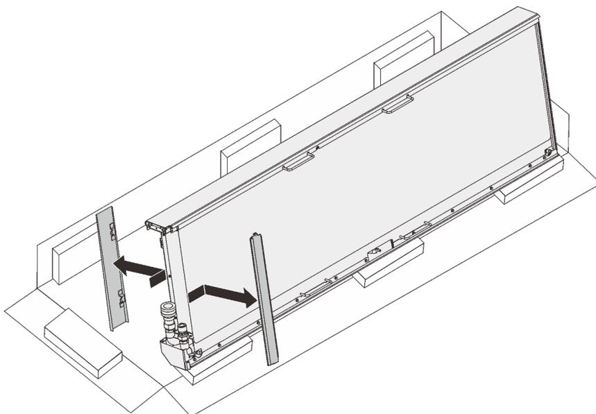
Рис. 94. Снятие панелей доступа к шлангам
