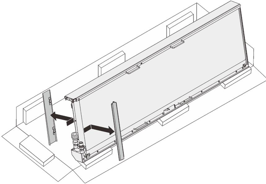
Рис. 154. Снятие панелей доступа к шлангам
