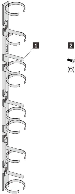
Рис. 8. Компоненты передней скобы кабельного органайзера 21U
