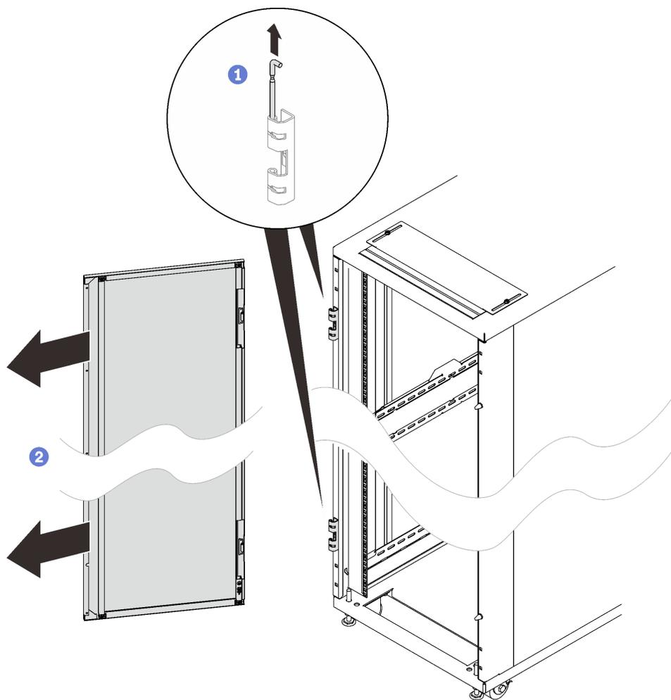
Рис. 132. Снятие дверцы
