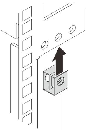
Рис. 75. Установка гайки с зажимом
