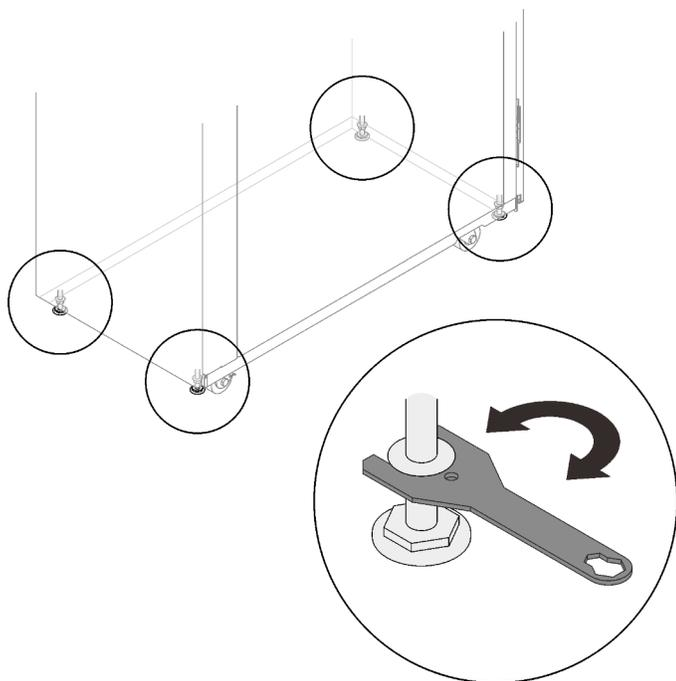
Рис. 192. Опускание регулировочных подкладок
