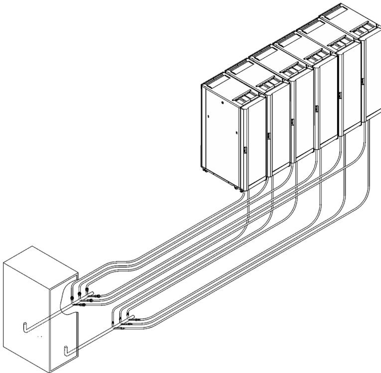
*Рис. 102. Типичный центральный коллектор (расположенный в центральном месте для нескольких водяных контуров)*
