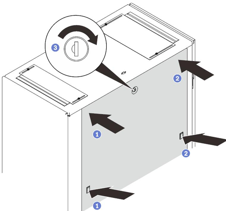
Рис. 81. Фиксация бокового кожуха
