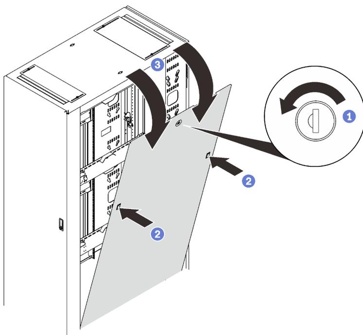
Рис. 79. Снятие бокового кожуха
