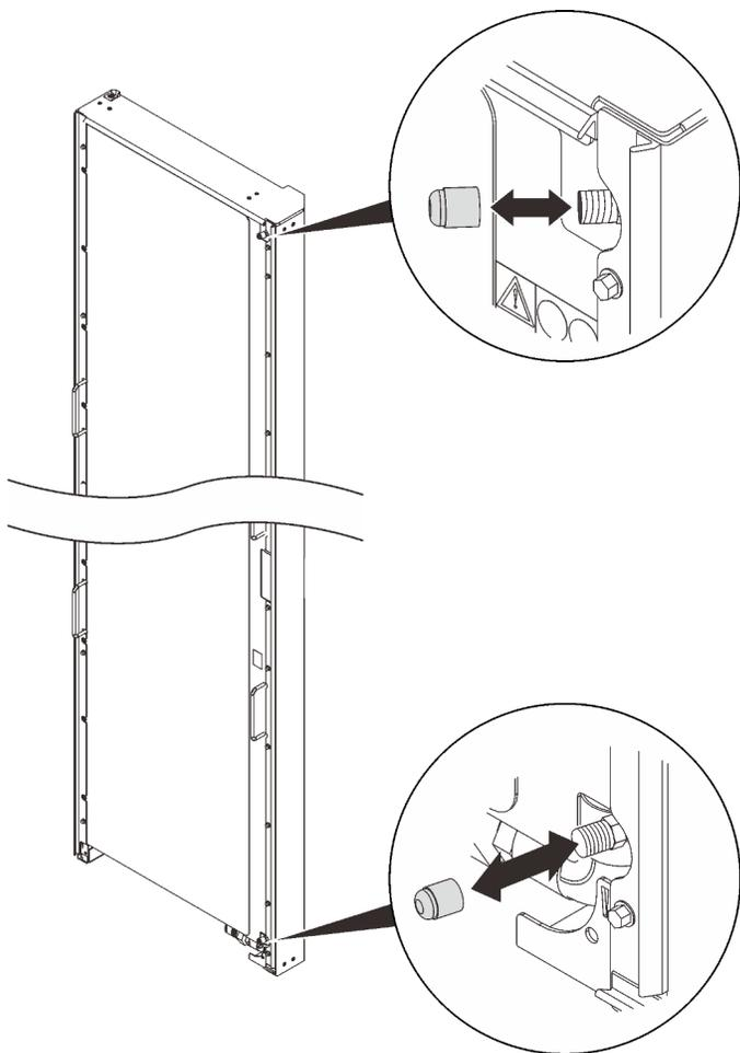
Рис. 148. Установка колпачков клапанов
