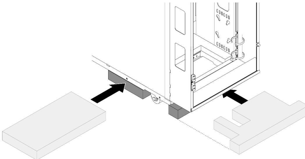
Рис. 68. Установка поролона для нижней стороны стойки
