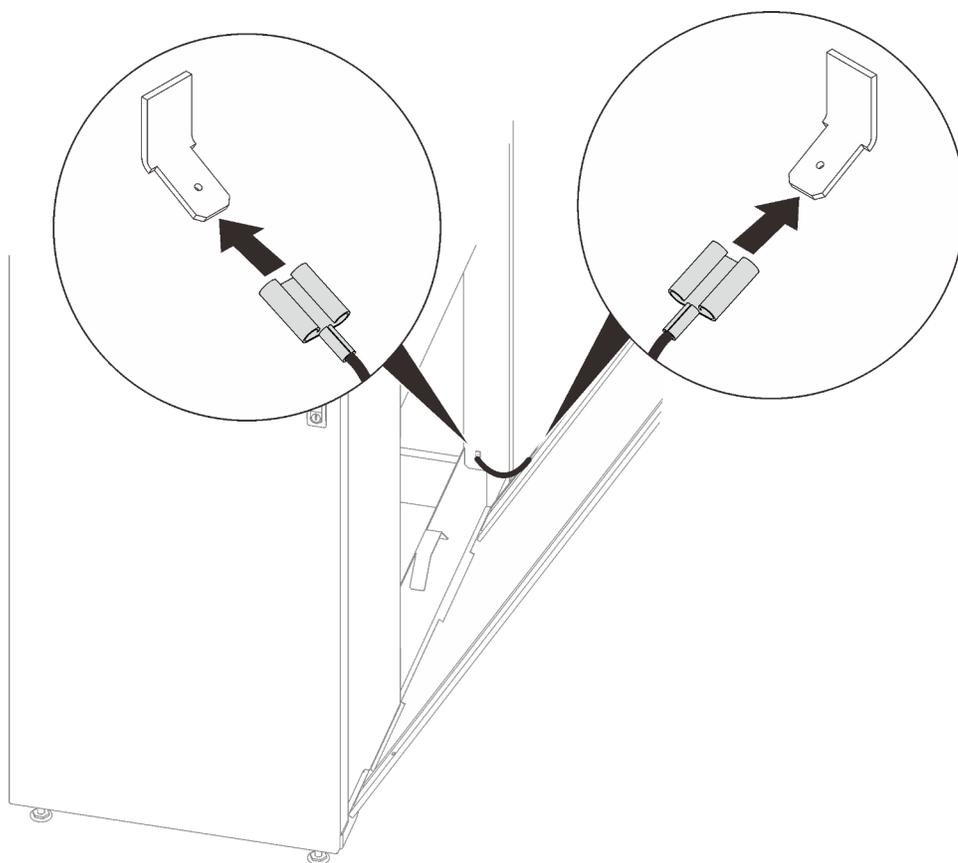
*Рис. 80. Установка провода перемычки заземления*
