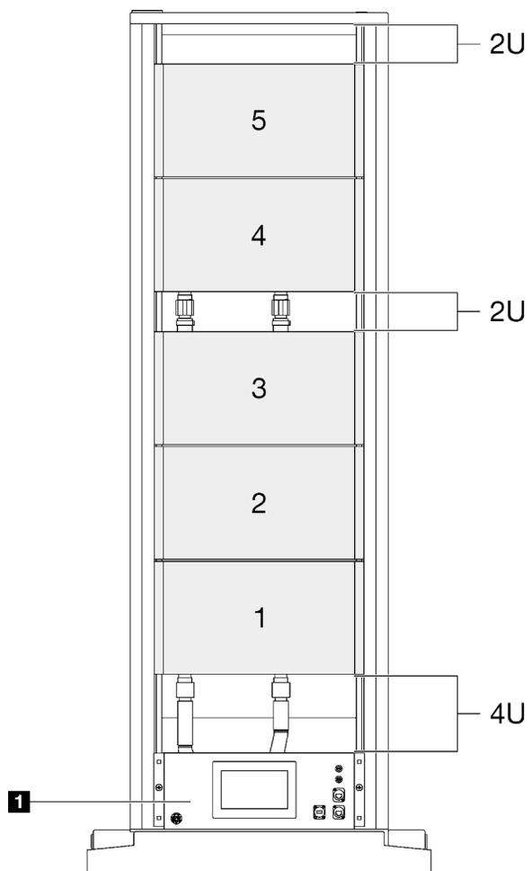
Рис. 4. Схема распределения охлаждающей жидкости внутри стойки — вид спереди
