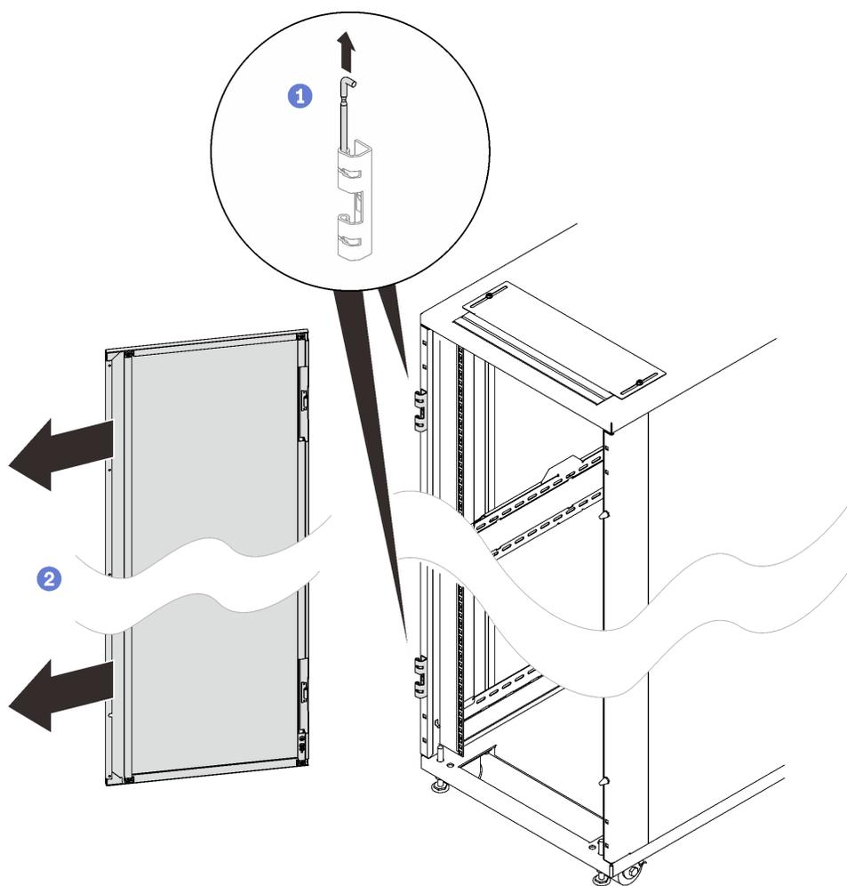
Рис. 130. Снятие дверцы
