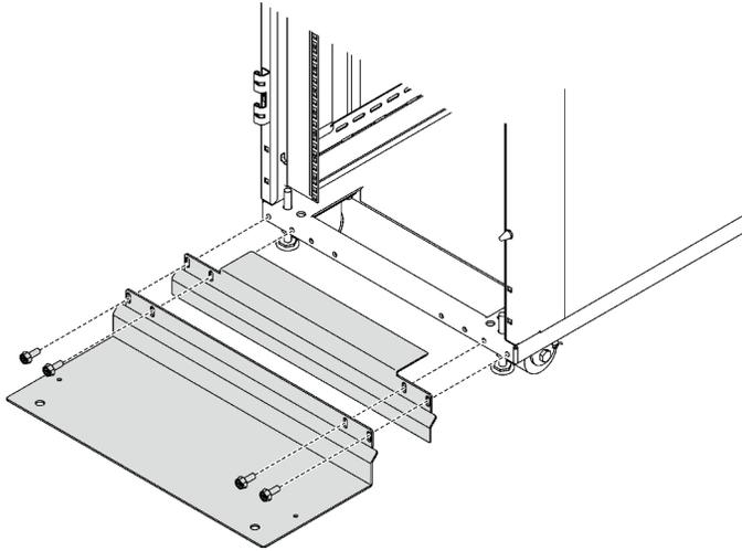
Шаг 3. Зафиксируйте стабилизатор на полу двумя винтами.
