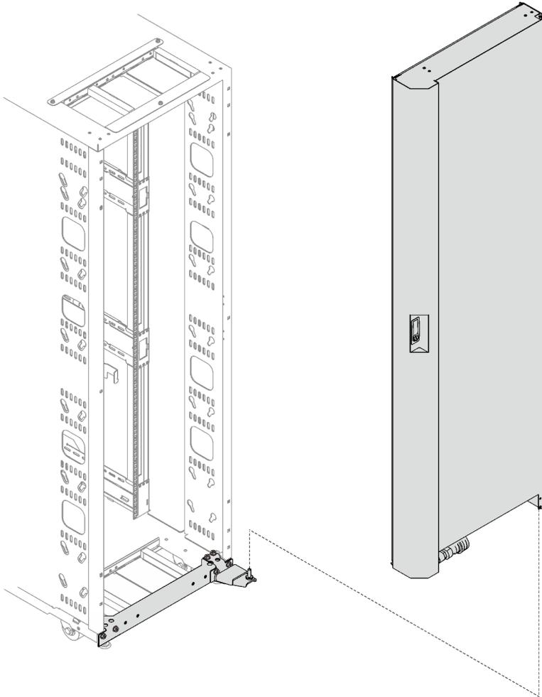
Рис. 96. Установка теплообменника в стойку
