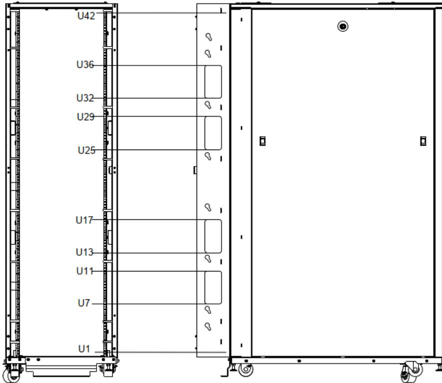
На каждой панели расширения есть четыре отверстия размером 89 (Ш) x 178 (В) мм:
