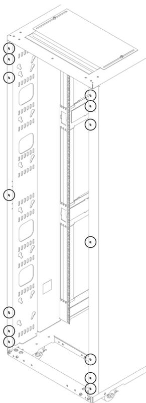
Рис. 53. Место установки закладных гаек
