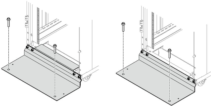
Рис. 35. Фиксация стабилизатора на полу
