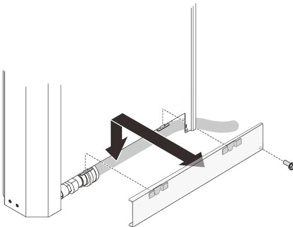
Рис. 140. Снятие внешней панели доступа к шлангам
