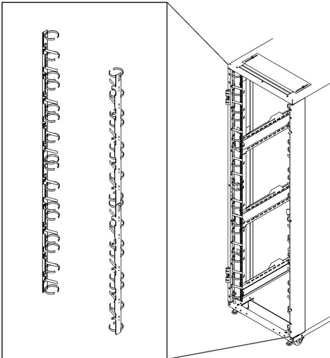
Рис. 120. Модуль кабельной стяжки
