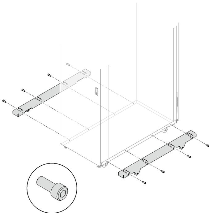
*Рис. 27. Снятие выносных опор*
