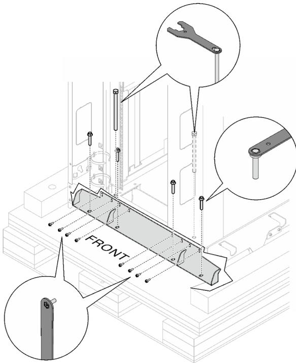
Рис. 19. Снятие передней транспортировочной скобы
