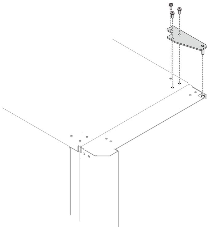
Рис. 97. Установка верхней петли
