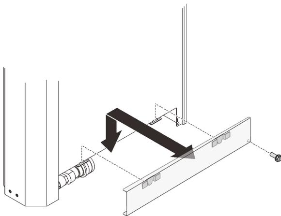
Рис. 105. Снятие внешней панели доступа к шлангам
