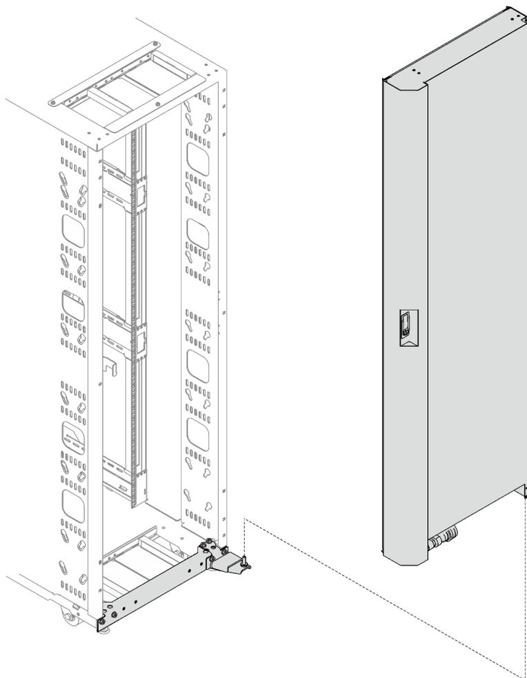
Рис. 156. Установка теплообменника в стойку
