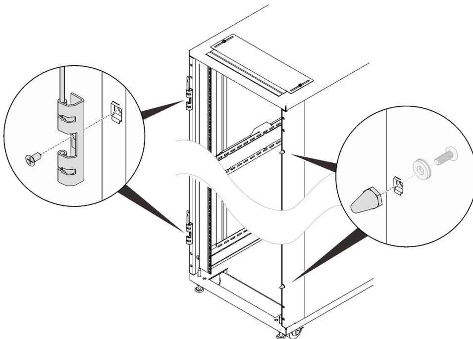
Рис. 39. Снятие дверных петель и дверных ограничителей
