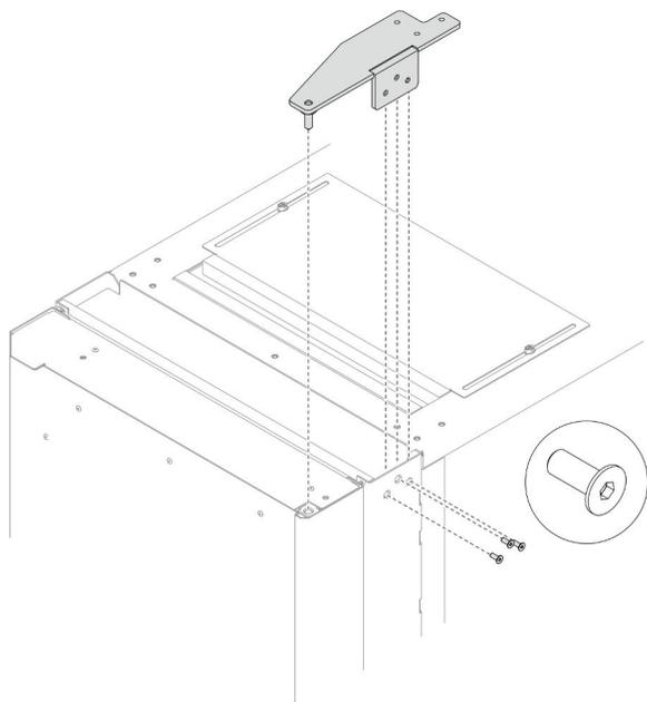
Рис. 150. Снятие верхней петли
