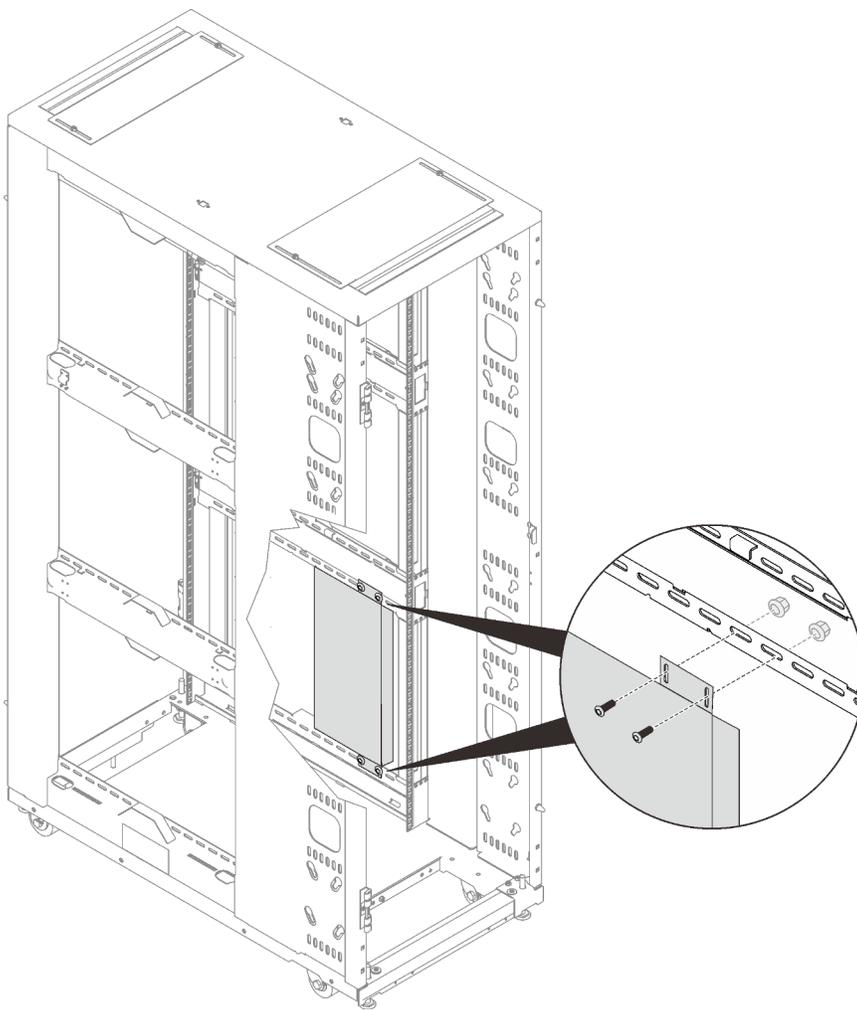
*Рис. 185. Установка устройства 1U в основной отсек стойки*
