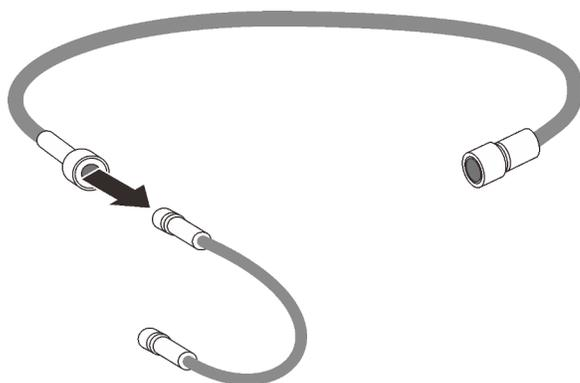
Рис. 143. Снятие удлинительного шланга
