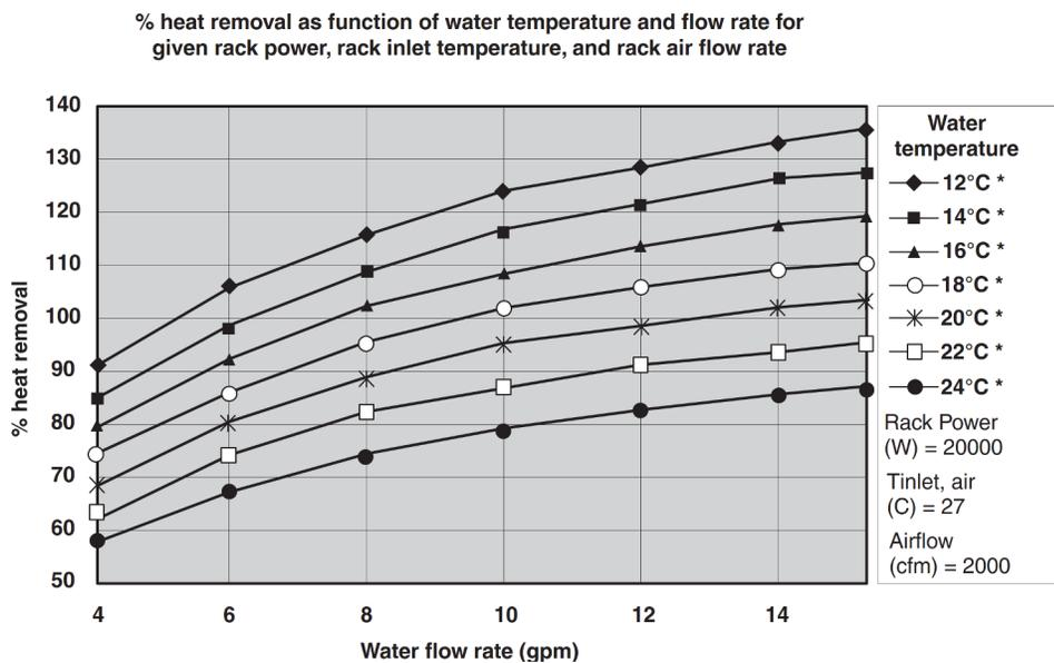
Рис. 12. Типичная производительность теплообменника, тепловая нагрузка 20 кВт
