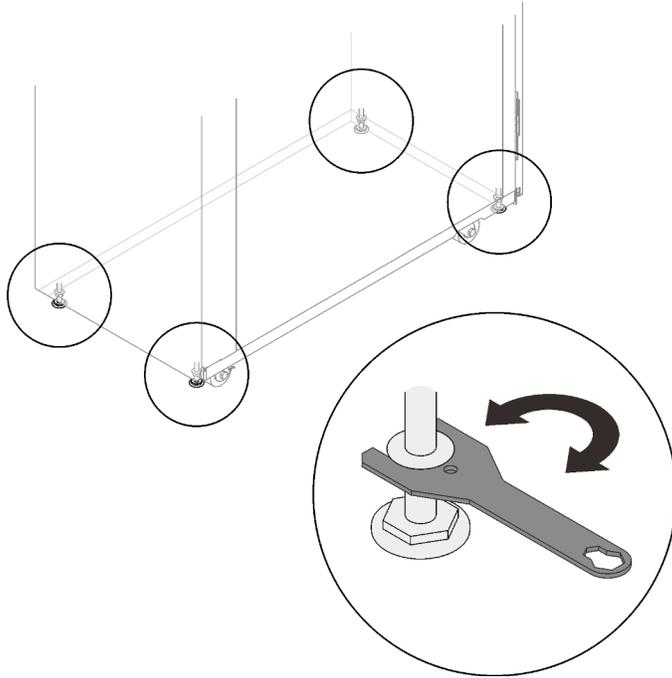
*Рис. 84. Опускание регулировочных подкладок*
