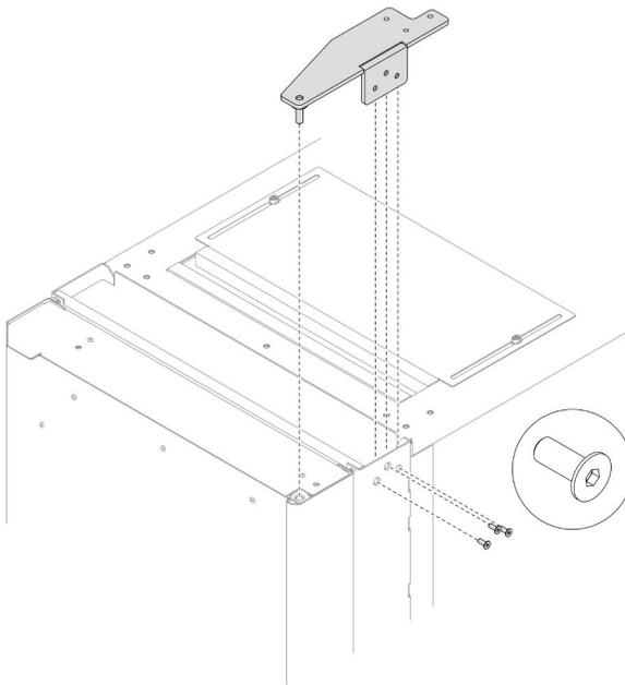
Рис. 158. Установка верхней петли
