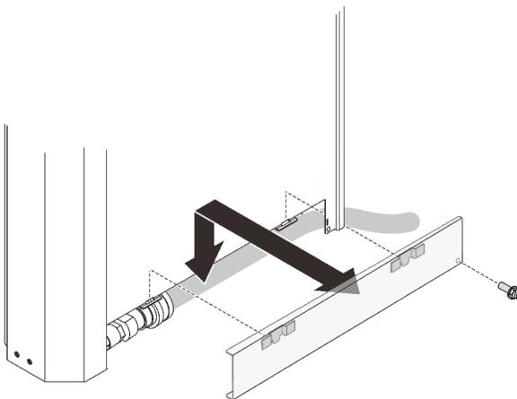
Рис. 112. Установка внешней панели доступа к шлангам
