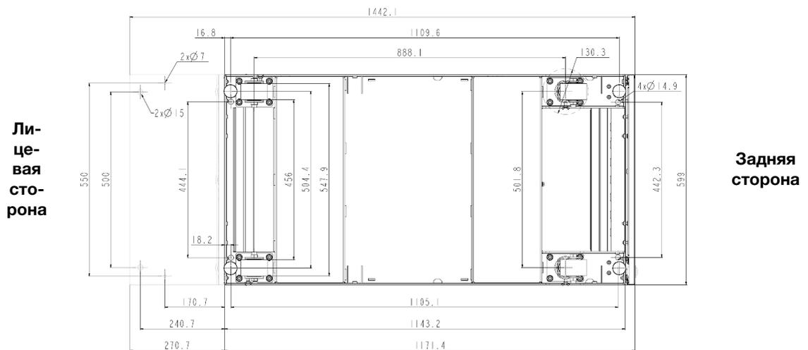
Рис. 36. Стойка с установленным стабилизатором
