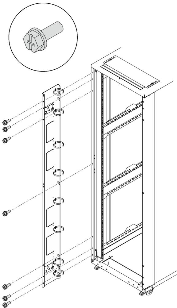
Рис. 41. Установка панели расширения
