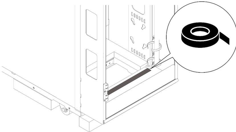
Рис. 65. Установка поролона для герметизации
