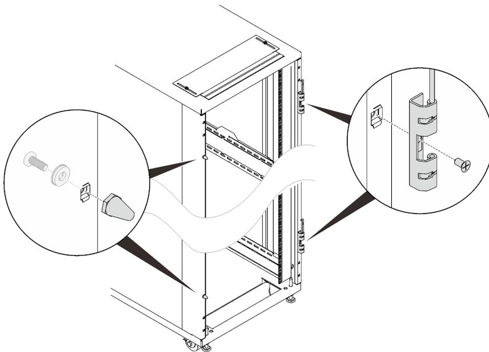
Рис. 86. Снятие дверных петель и дверных ограничителей
