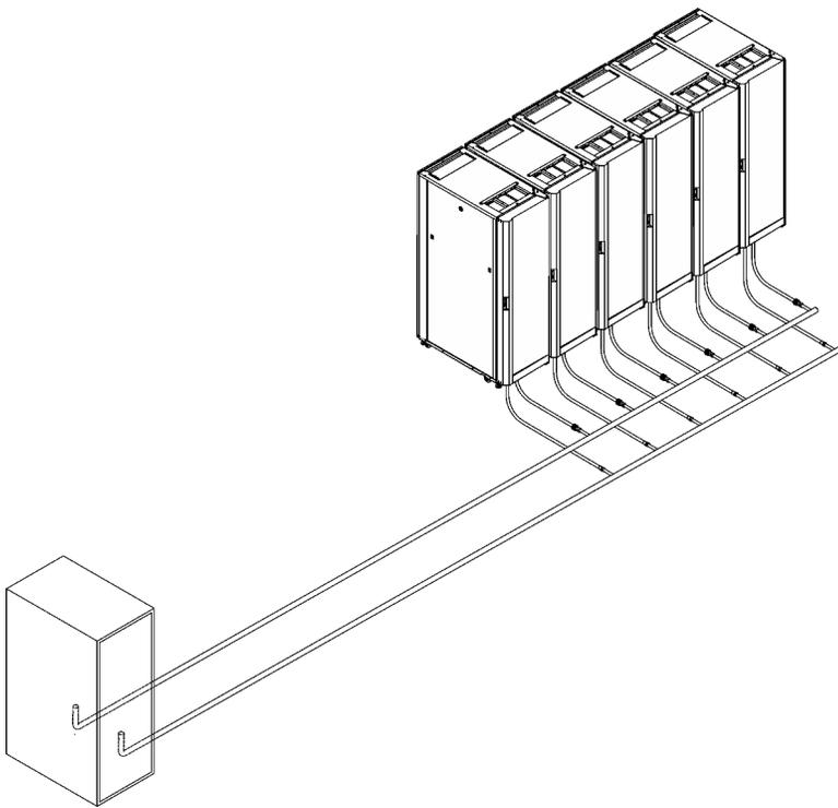
Рис. 103. Типичный удлиненный коллектор (вдоль проходов между стойками)
