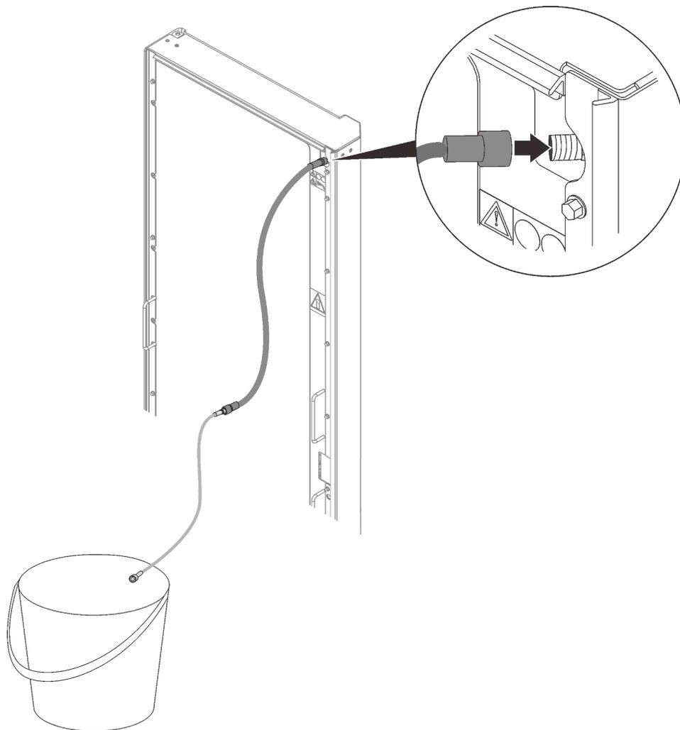
Рис. 108. Установка инструмента для удаления воздуха
