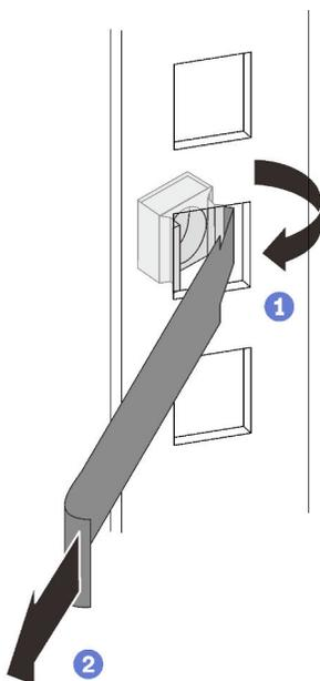
Рис. 77. Установка закладной гайки
