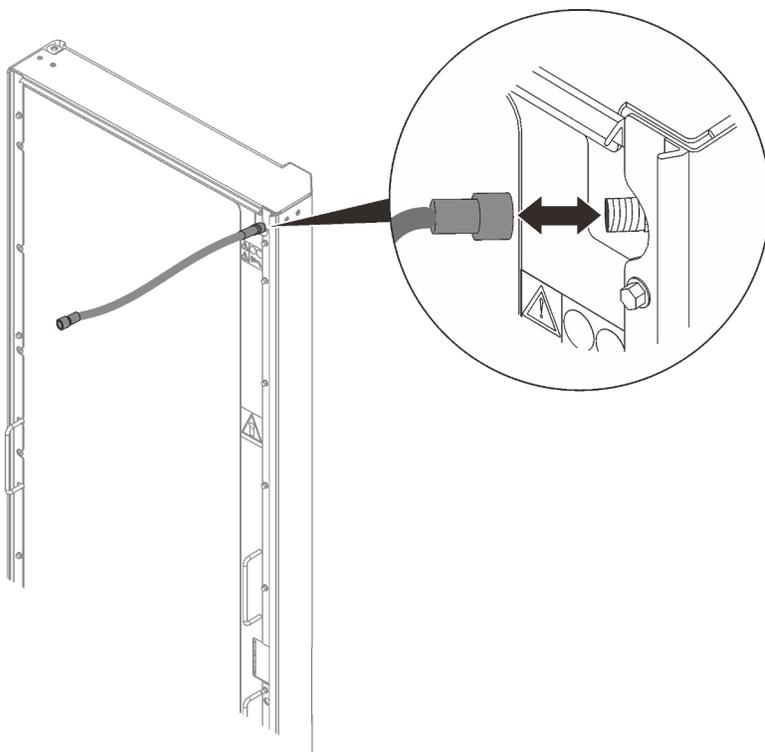
Рис. 144. Вставка удлинительного шланга инструмента для удаления воздуха
