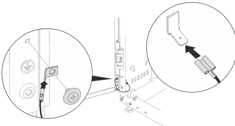
Рис. 78. Установка комплекта заземления стойки
