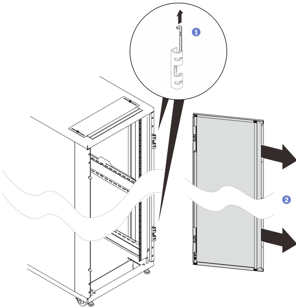
Рис. 85. Снятие дверцы
