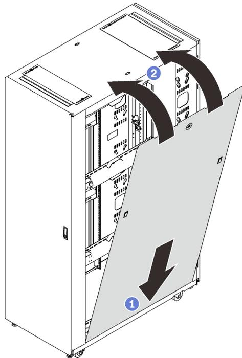
Рис. 128. Установка бокового кожуха
