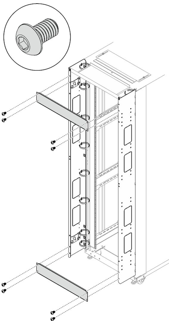
Рис. 173. Установка опорных скоб
