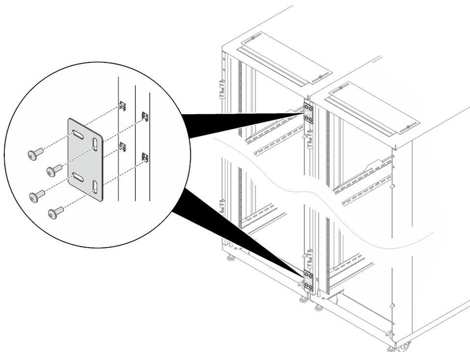
Рис. 31. Установка крепежных скоб
