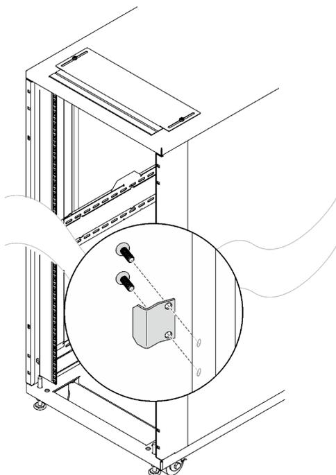
Рис. 40. Снятие дверной защелки
