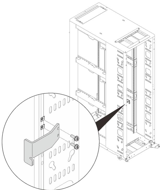
Рис. 88. Установка пластины защелки
