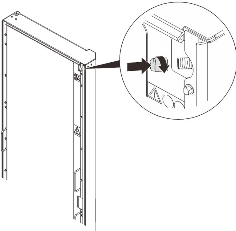
Рис. 110. Установка колпачка клапана
