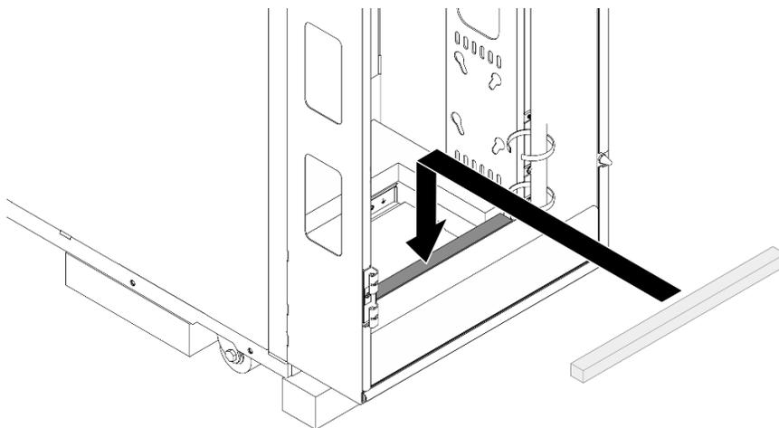
Рис. 67. Установка поролона для задней стороны стойки
