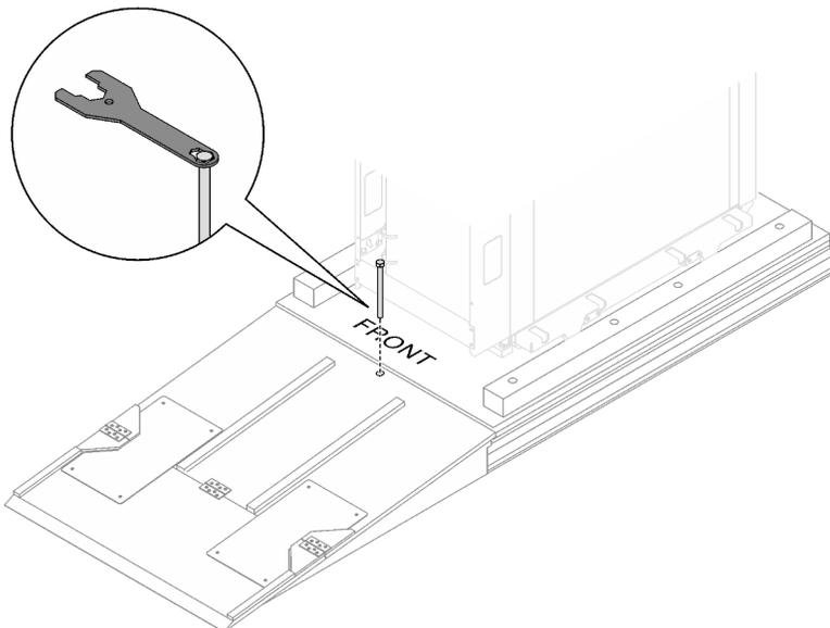
Рис. 23. Фиксация рампы на поддоне
