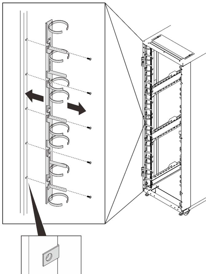
Рис. 196. Снятие передней скобы кабельного органайзера 21U
