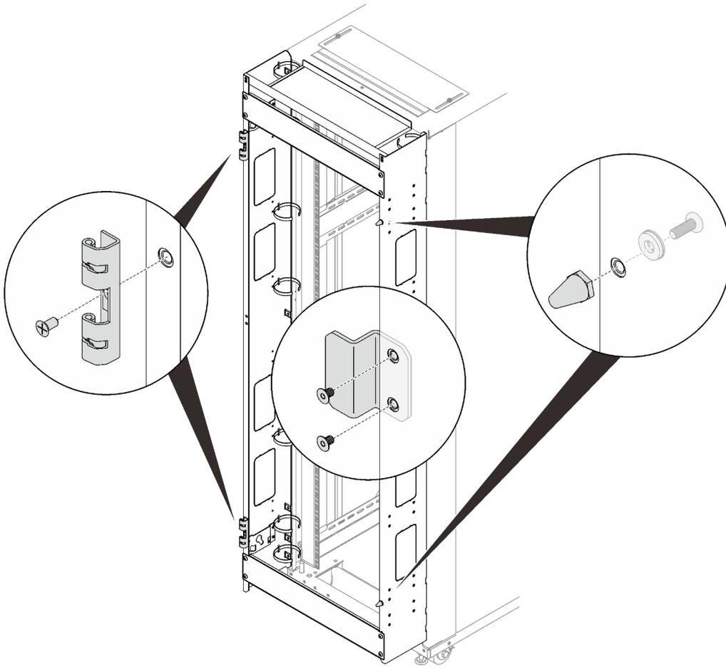
Рис. 176. Снятие дверных петель, дверных ограничителей и защелки
