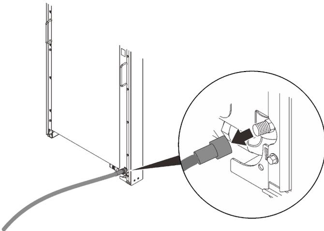
Рис. 147. Снятие инструмента для удаления воздуха
