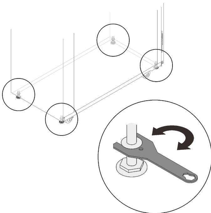
*Рис. 21. Подъем регулировочных подкладок*
