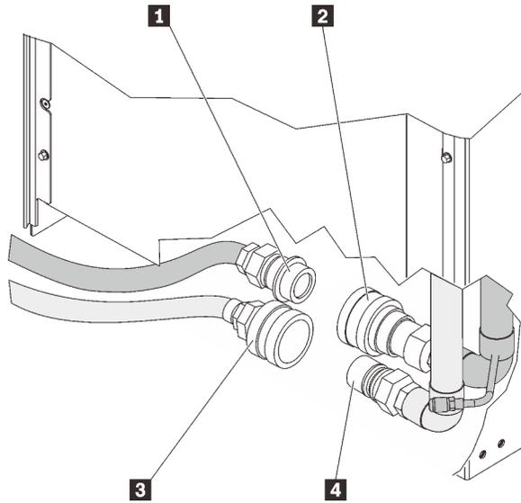
Рис. 141. Подающий и возвратный шланги и муфты коллектора
