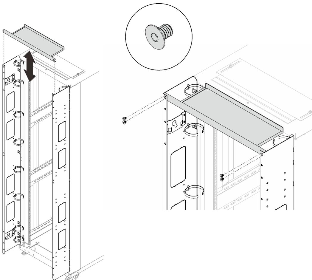
Рис. 43. Установка верхнего кожуха комплекта расширения
