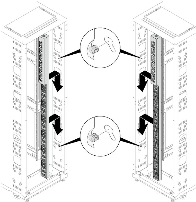
Рис. 113. Установка 0U PDU
