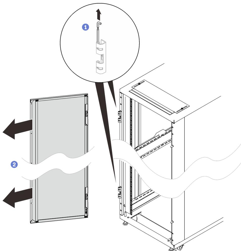
Рис. 50. Снятие дверцы
