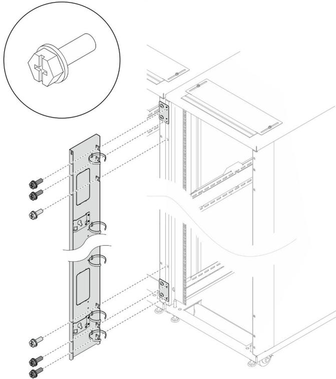
Рис. 42. Установка панели расширения (с комплектом крепления стоек)
