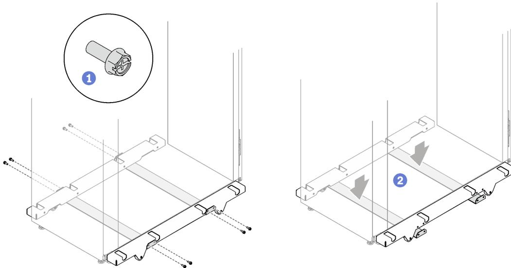
Рис. 26. Снятие стабилизирующих планок выносных опор
