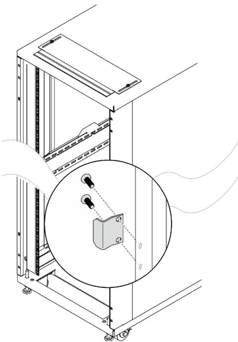
Рис. 180. Установка дверной защелки
