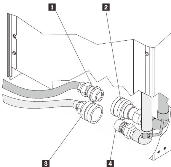
Рис. 107. Подающий и возвратный шланги и муфты коллектора
