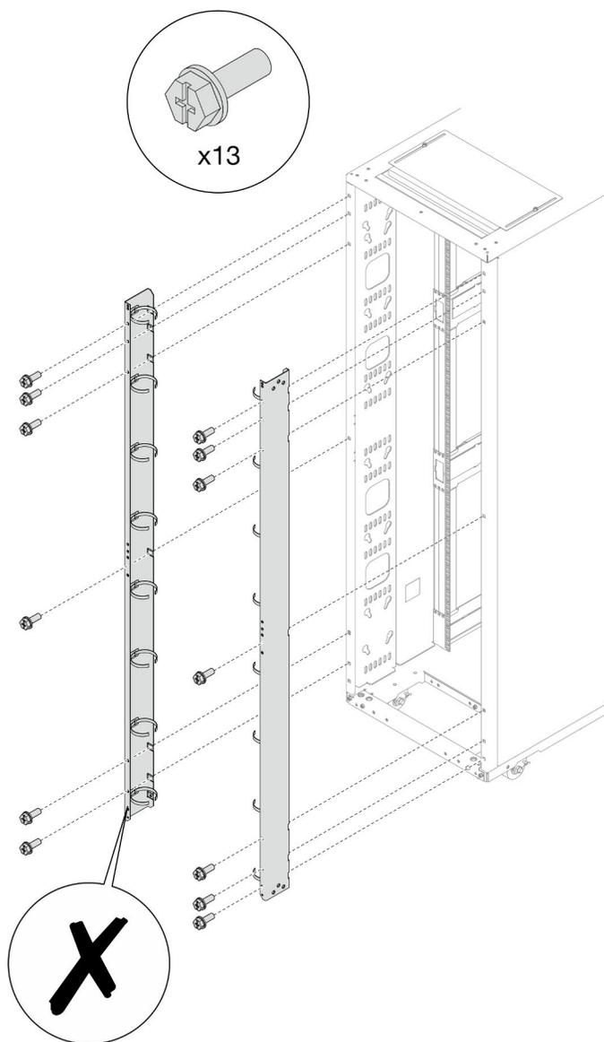
Рис. 56. Установка панели расширения
