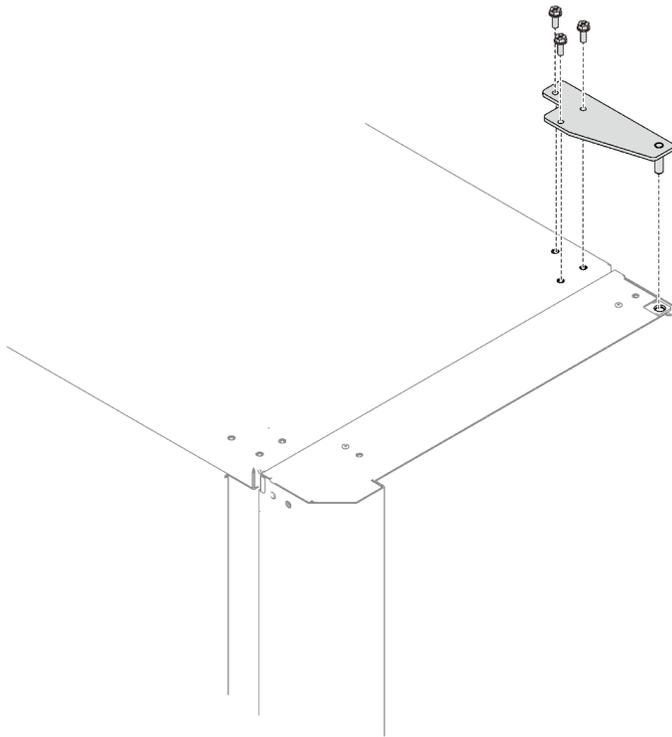
Рис. 149. Снятие верхней петли
