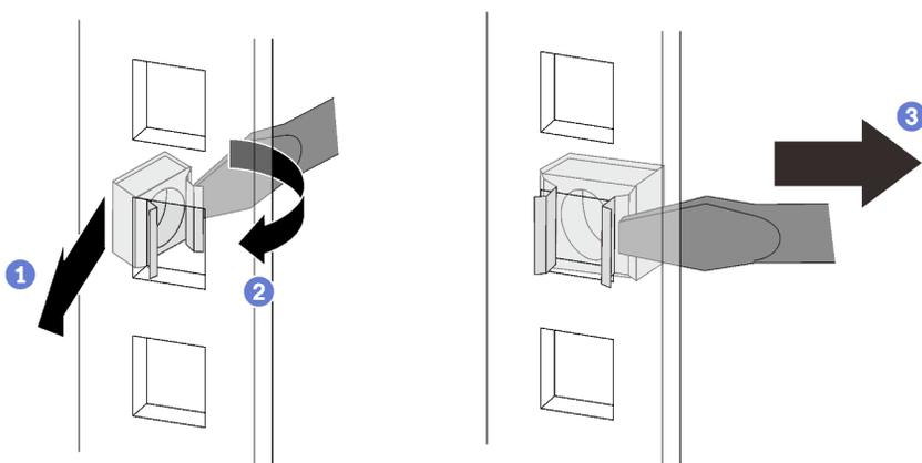
Рис. 76. Установка закладной гайки
