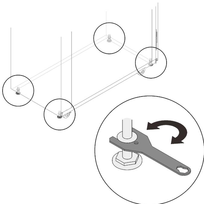
Рис. 189. Опускание регулировочных подкладок
