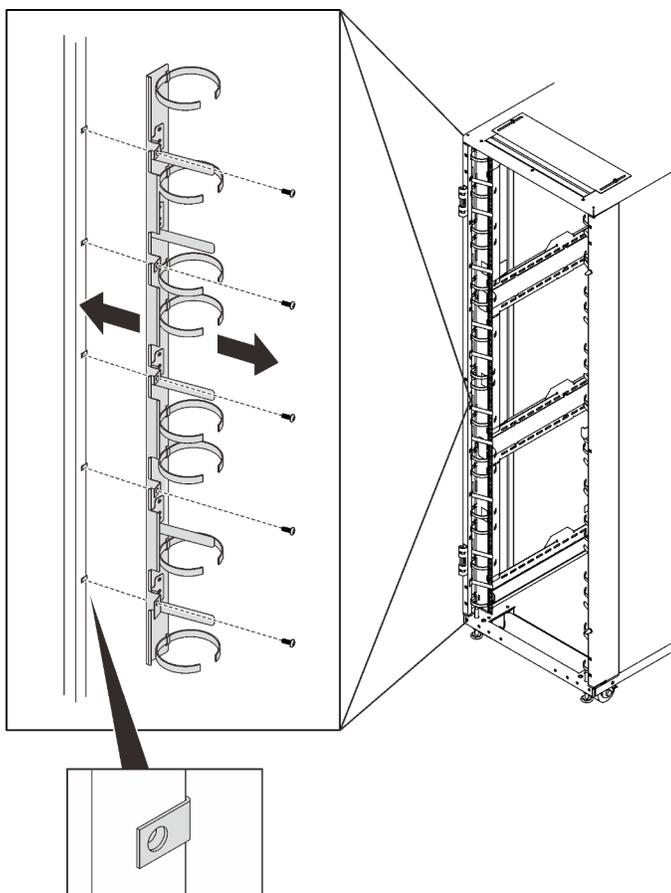
Рис. 198. Установка передней скобы кабельного организера 21U
