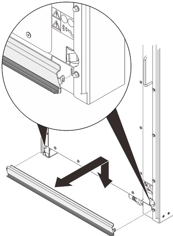
Рис. 159. Снятие внутренней панели доступа к шлангам
