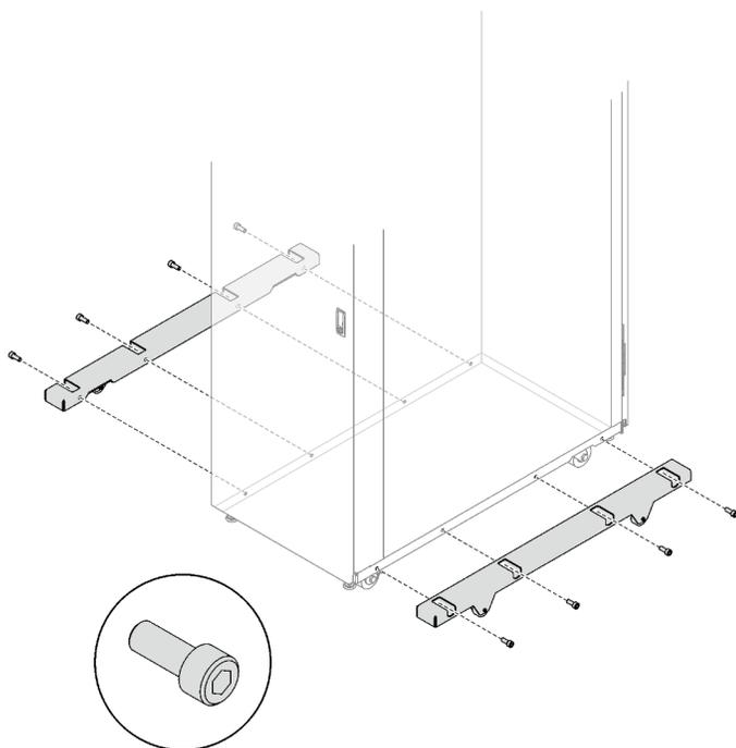
Рис. 193. Установка выносных опор
