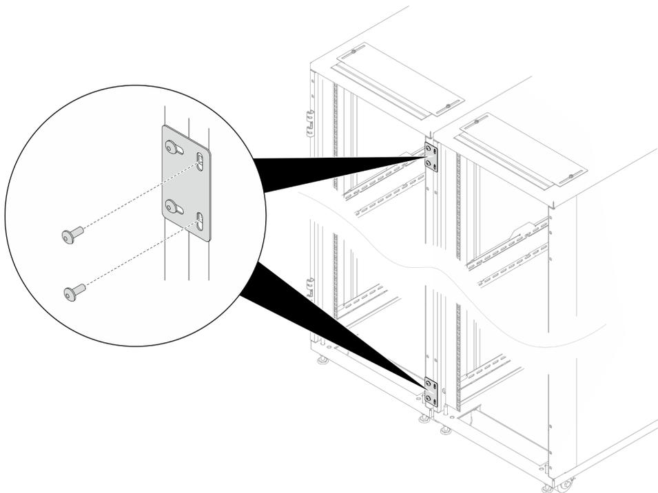
Рис. 37. Снятие винтов для подготовки к установке комплекта расширения
