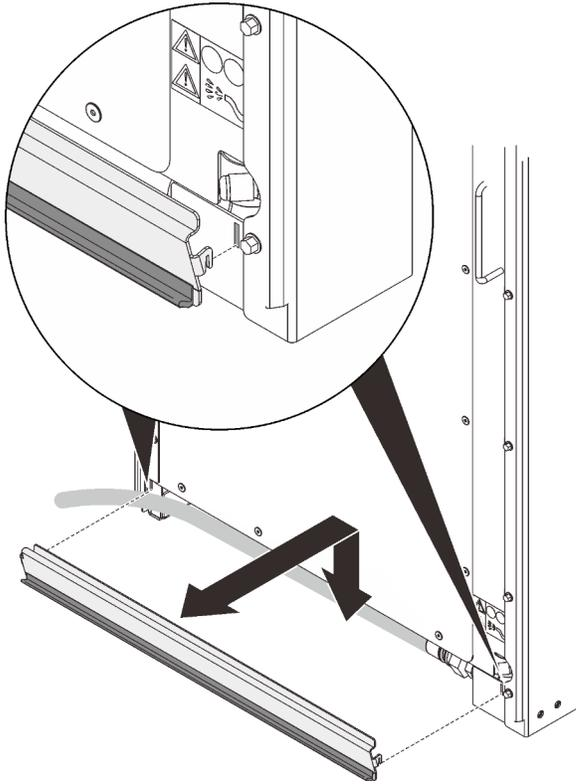
Рис. 166. Установка внутренней панели доступа к шлангам
