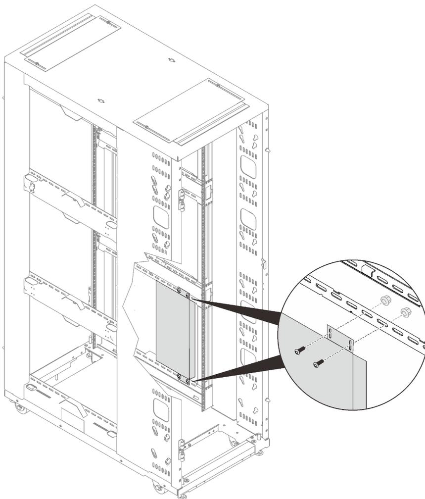
Рис. 114. Установка устройства 1U в основной отсек стойки
