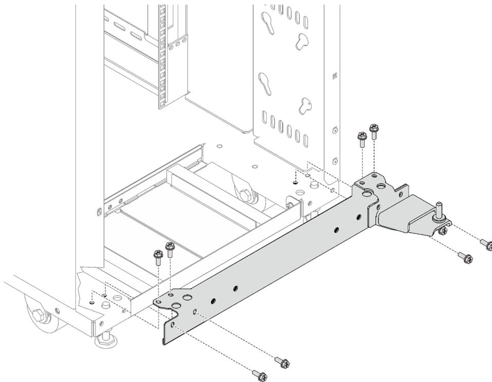
*Рис. 92. Установка блока нижней петли*
