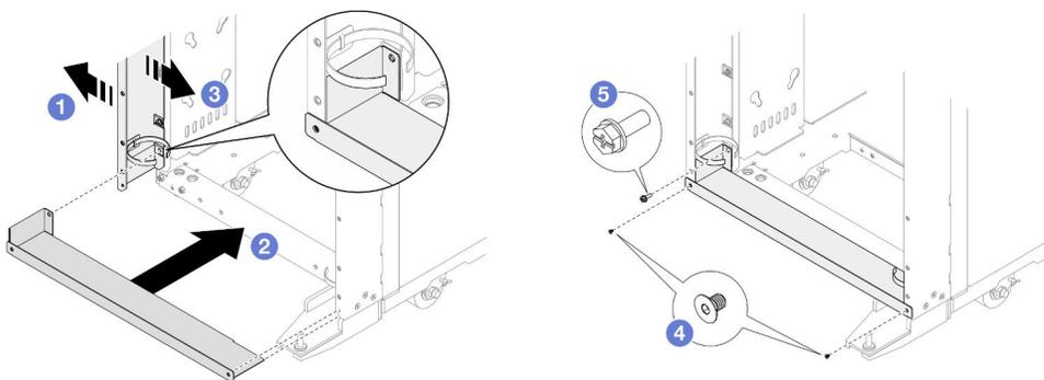
Рис. 59. Фиксация нижнего кожуха комплекта расширения
