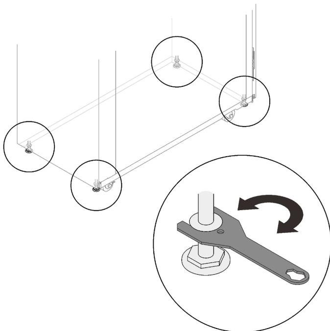
Рис. 195. Укорачивание регулировочных подкладок
