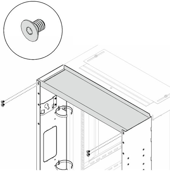
Рис. 57. Установка верхнего кожуха комплекта расширения
