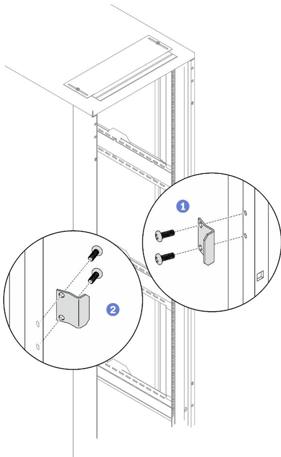
Рис. 134. Изменение направления установки дверной защелки
