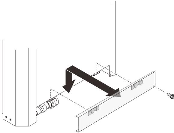
Рис. 160. Снятие внешней панели доступа к шлангам
