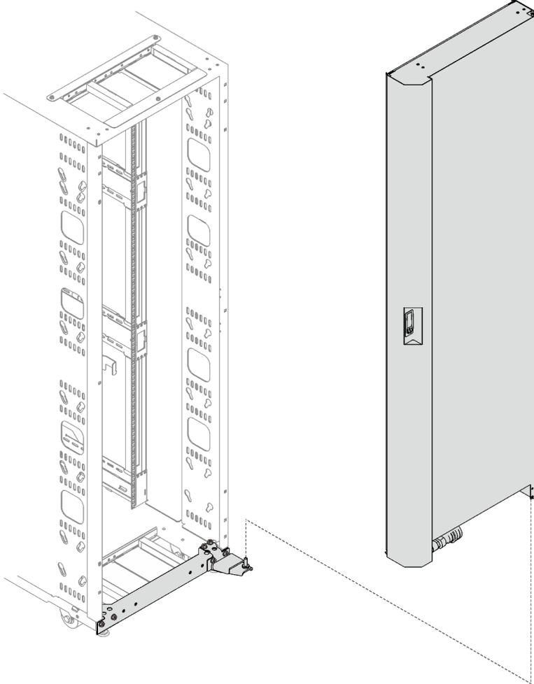
Рис. 152. Снятие теплообменника со стойки
