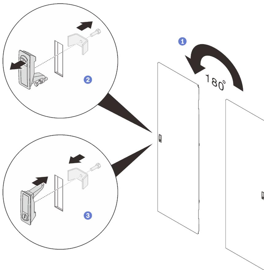
Рис. 137. Изменение направления установки дверной ручки
