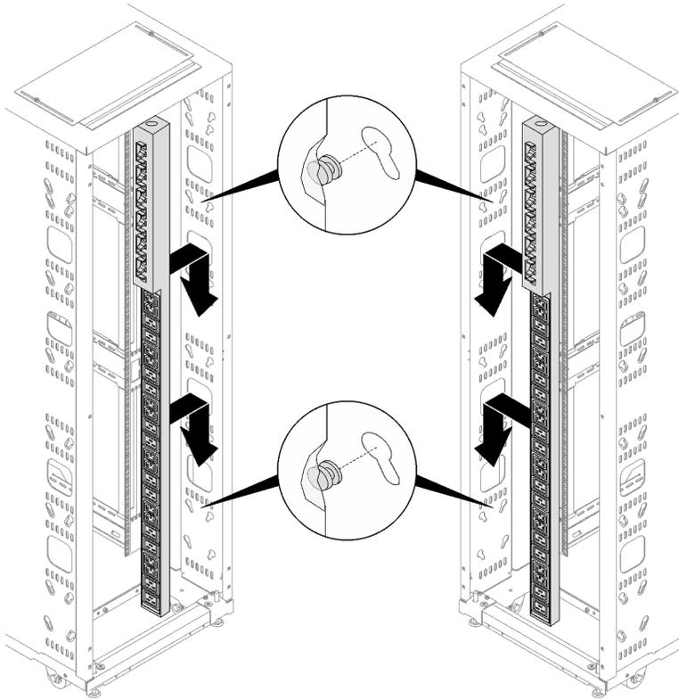
Рис. 183. Установка 0U PDU
