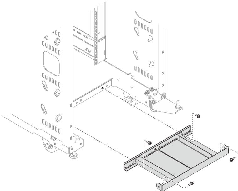
Рис. 91. Установка нижнего дефлектора
