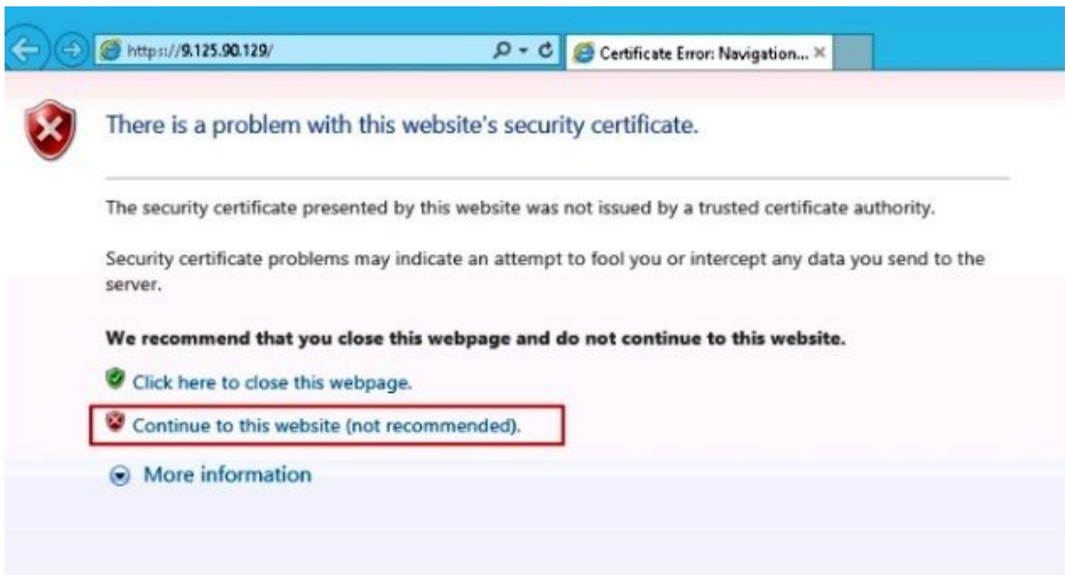
그림 69. Lenovo Flex System 새시 웹 콘솔을 열 때 인증서 오류 발생
