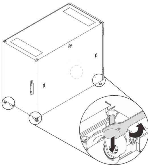
Figura 13. Ajustar la pata del armario bastidor
