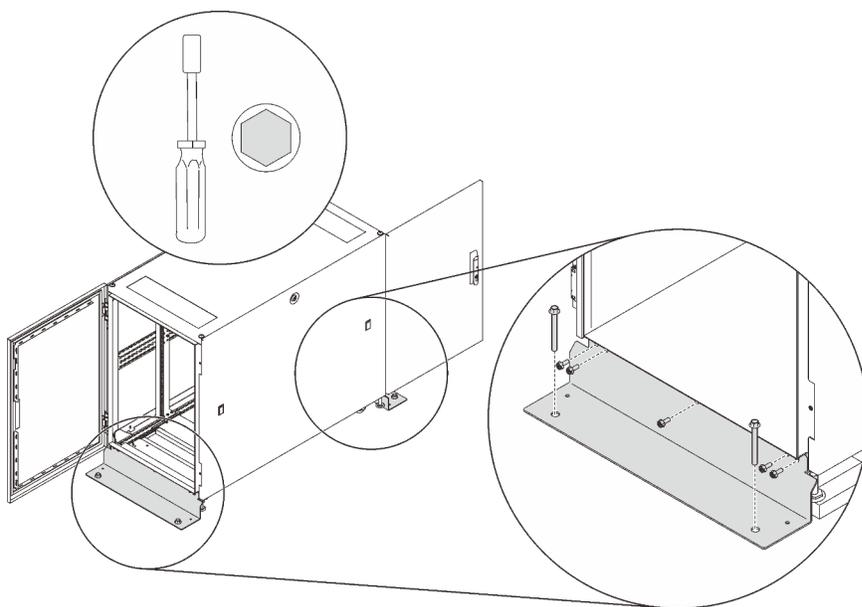
Figura 15. Instalar los soportes de perno
