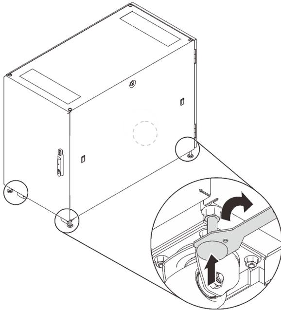
Figura 9. Ajustar las patas del armario bastidor
