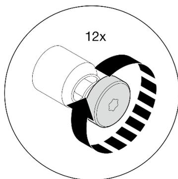
図 141. 下部多岐管へのねじの取り付け
