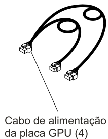
Figura 169. Adaptadores GPU do conjunto do PCI traseiro com conexão do cabo de alimentação da placa GPU
