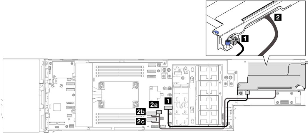
그림 12. PCIe 라이저 케이블 배선
