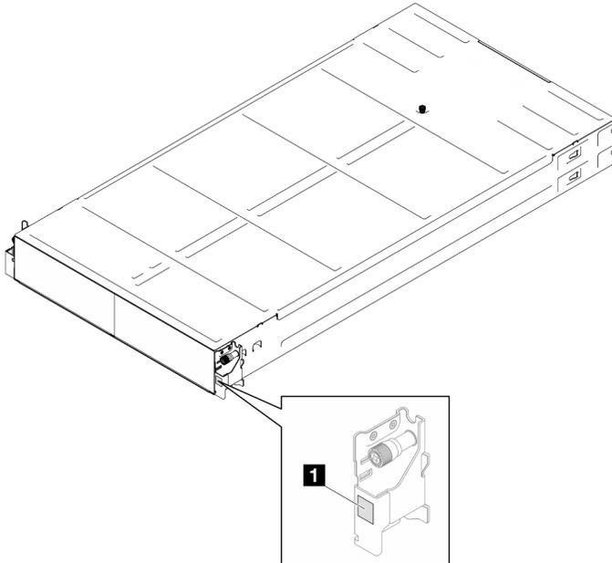
Figure 17. Emplacement de l'étiquette d'identification sur le châssis
