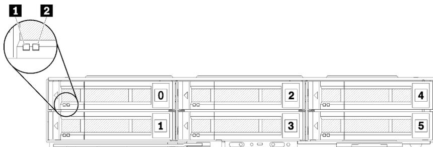
Figure 18. Configuration à six unités de 2,5 pouces et numérotation des baies d'unité
