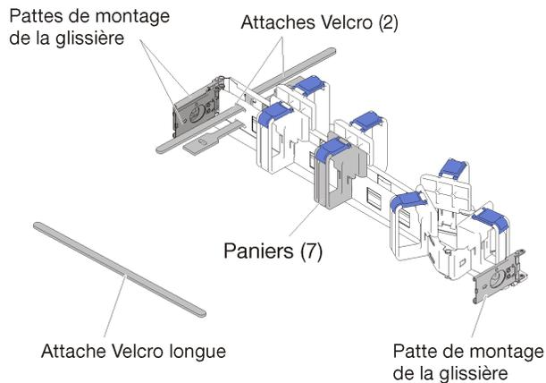
Figure 1. Contenu de la boîte du bras de routage des câbles
