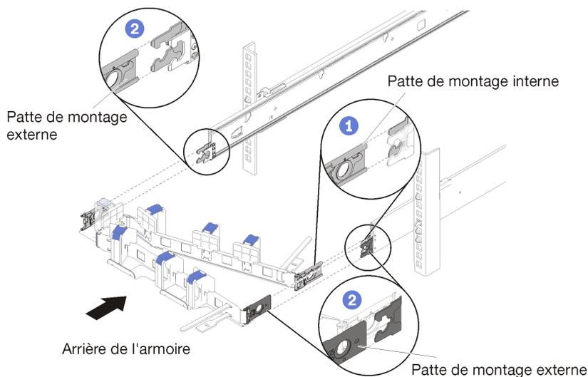
Figure 2. Installation du bras de routage des câbles
