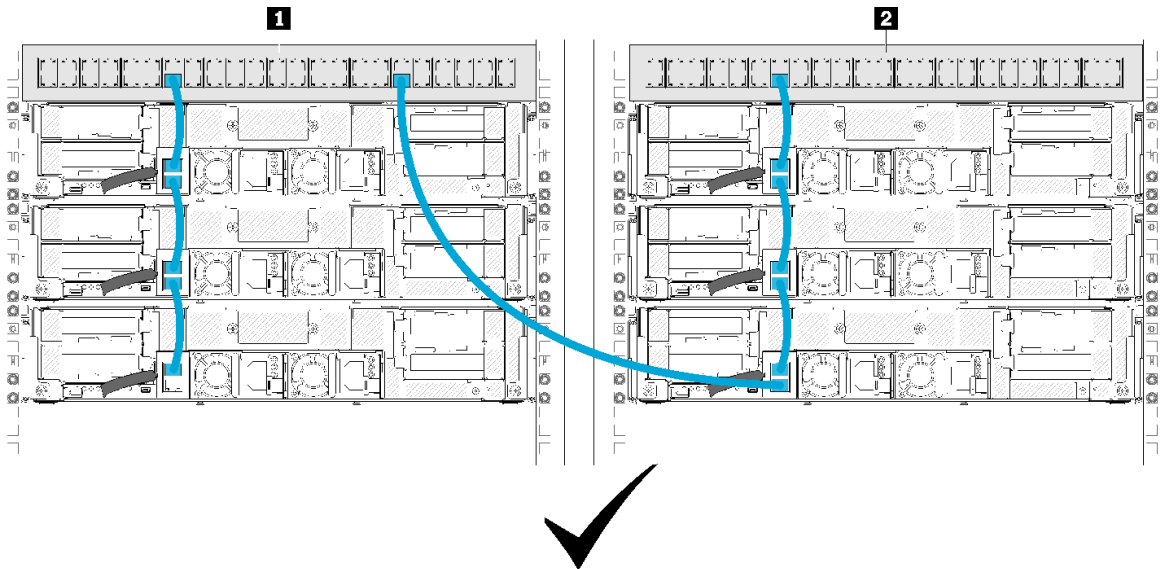
図59. クロス・ラック・エンクロージャー・チェーンの例
