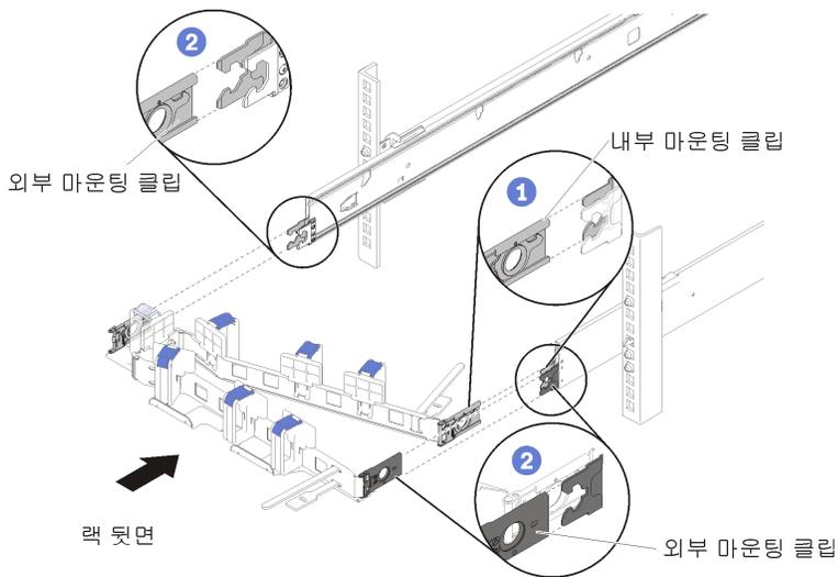
**그림 2. 케이블 관리 암 설치**
