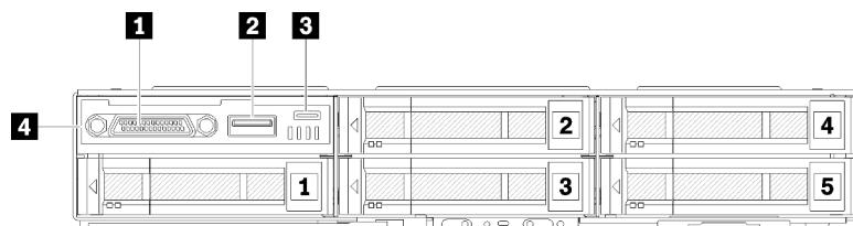
Figura 19. Configuração de cinco unidades de 2,5 polegadas com o módulo breakout KVM e numeração de compartimento de unidade
