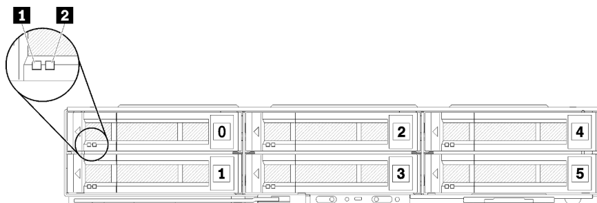
Figura 18. Configuração de seis unidades de 2,5 polegadas e numeração do compartimento de unidade
