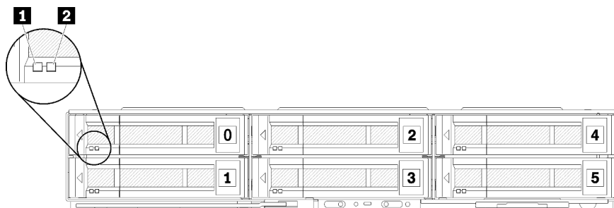
Рис. 18. Конфигурация с шестью 2,5-дюймовыми дисками и нумерация отсеков для дисков
