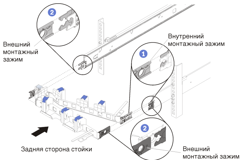
Рис. 2. Установка кабельного органайзера
