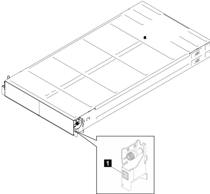
Figure 18. Emplacement de l'étiquette d'identification sur le châssis
