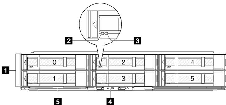
Figure 2. Configuration avec six SSD SAS/SATA/NVMe de 2,5 pouces
