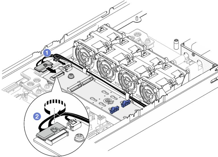
Figure 72. Connexion du câble à l'adaptateur d'amorçage NVMe M.2
