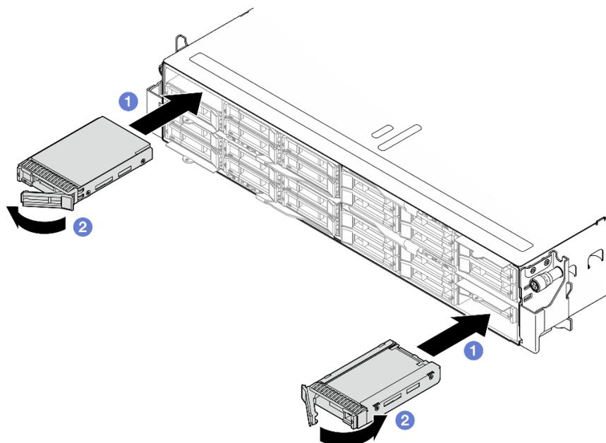
Figure 61. Installation d'un disque SSD
