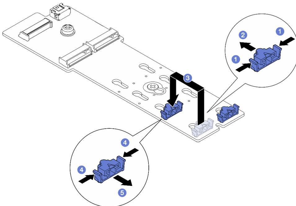
Figure 75. Ajustement du crochet de retenue M.2
