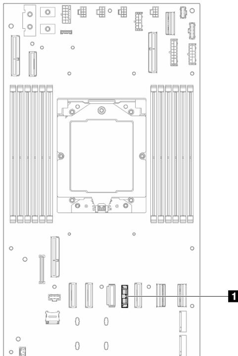
Figure 40. Emplacement du socket de la pile CMOS
