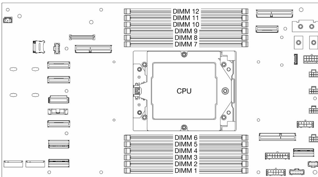
Figure 84. Disposition des modules de mémoire et des processeurs
