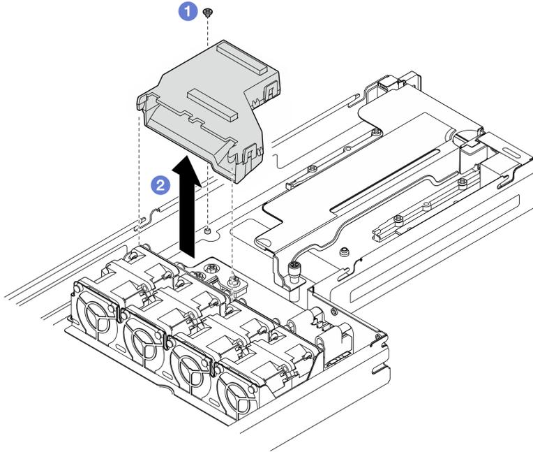
Figure 56. Retrait du conduit de ventilation du GPU
