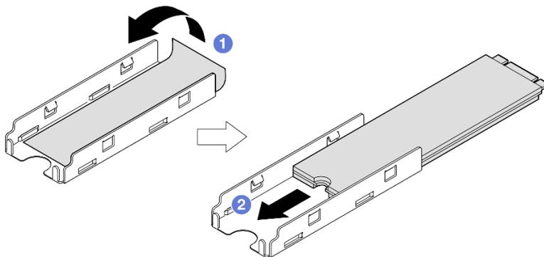
Figure 77. Installation d'un tampon thermique et d'une unité M.2 dans le plateau
