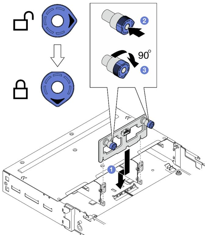
Figure 55. Installation du fond de panier d'E-S avant
