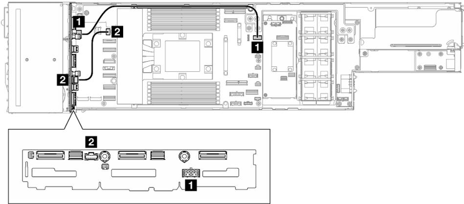
Figure 134. Bande latérale du fond de panier d'unité et cheminement des câbles d'alimentation
