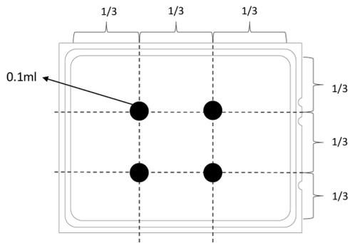
Figure 110. Application de pâte thermoconductrice
