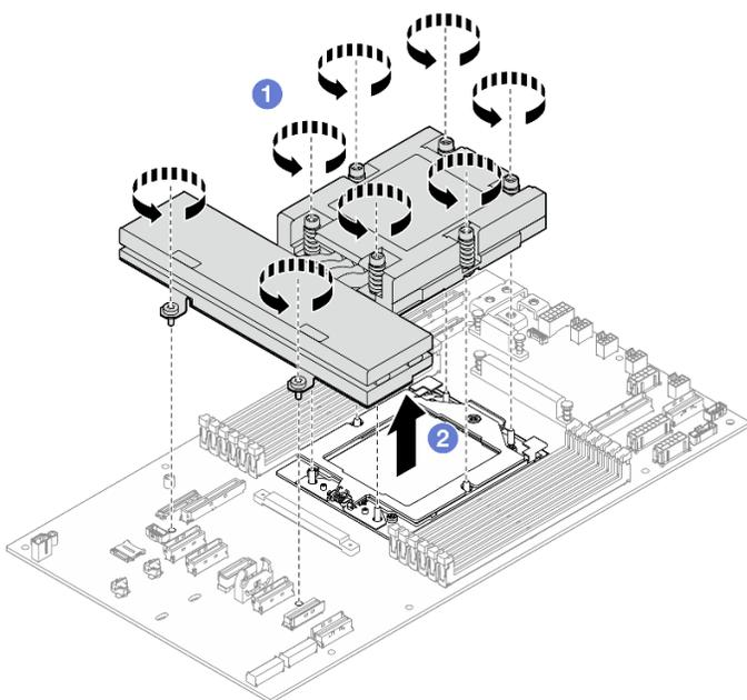
Figure 106. Retrait d'un dissipateur thermique
