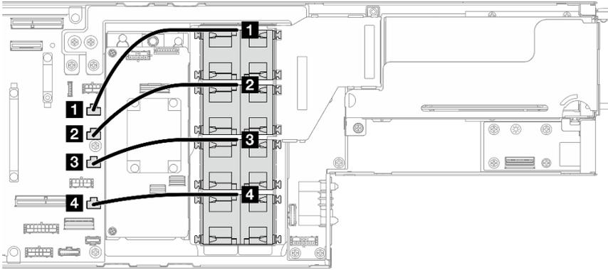
Figure 141. Cheminement des câbles de ventilateur
