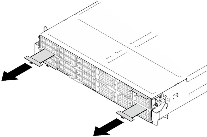
Figure 13. Étiquette d'accès réseau Lenovo XClarity Controller figurant sur l'étiquette amovible
