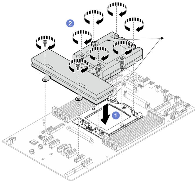
Figure 111. Installation d'un dissipateur thermique
