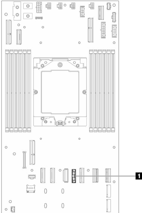
Figure 42. Emplacement du socket de la pile CMOS
