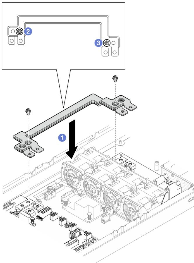
Figure 101. Installation de la barre-bus d'alimentation
