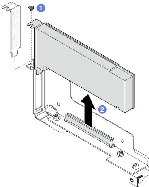
Figure 94. Retrait d'un adaptateur PCIe
