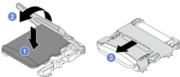
Figure 89. Installation d'une carte MicroSD
