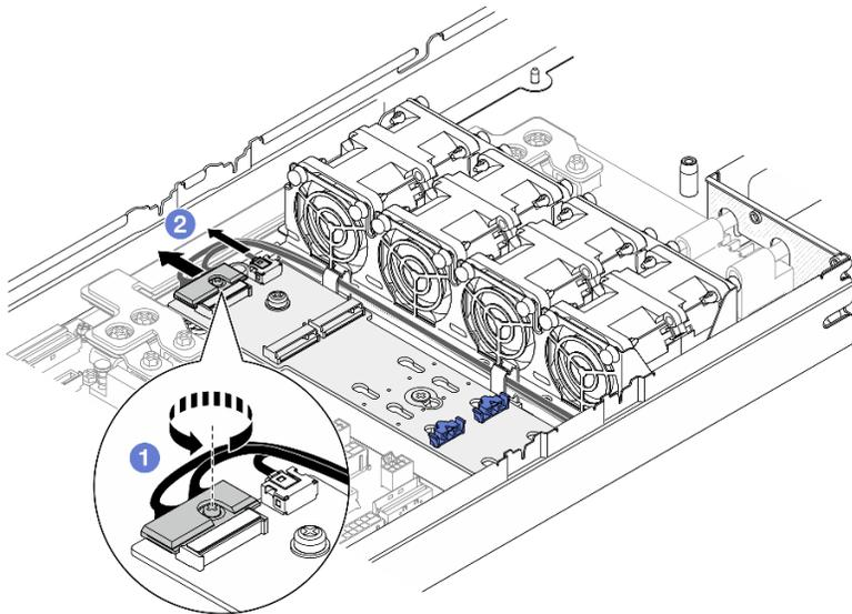
Figure 66. Déconnexion du câble de l'adaptateur d'amorçage NVMe M.2
