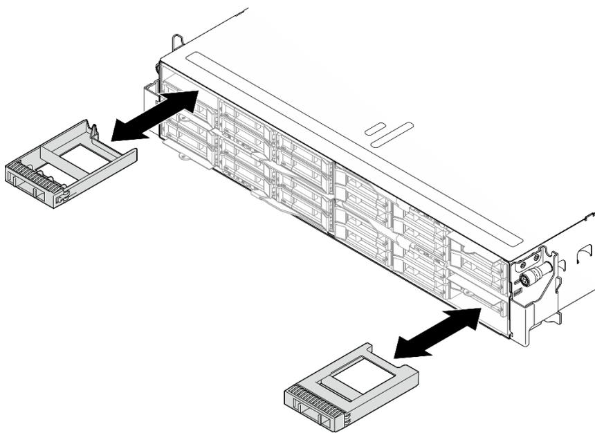
Figure 59. Remplacement d'un obturateur d'unité
