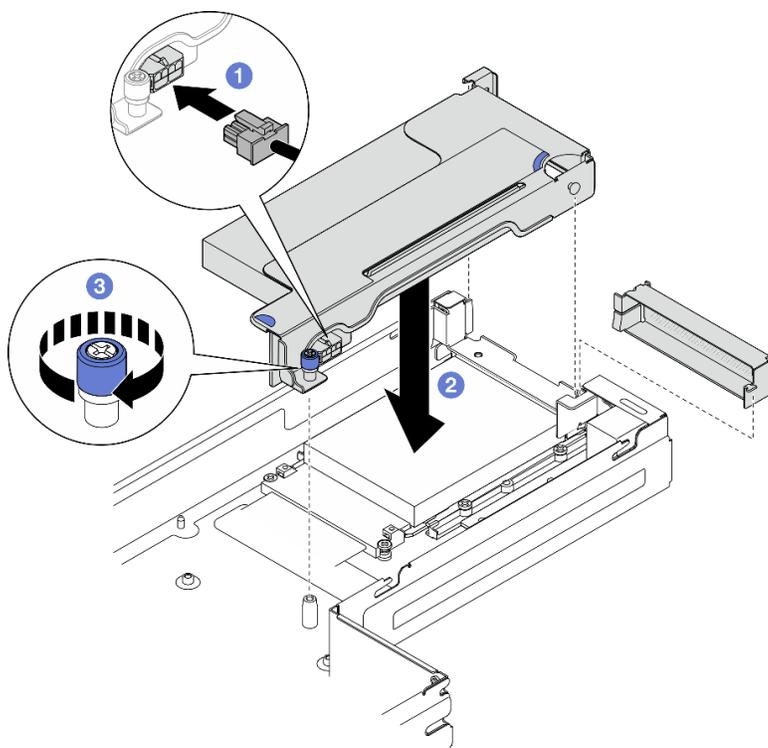
Figure 98. Installation de l'assemblage de cartes mezzanines PCIe
