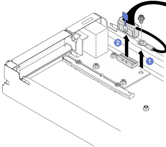
Figure 112. Retrait du câble d'E-S arrière et du câble de mise à la terre
