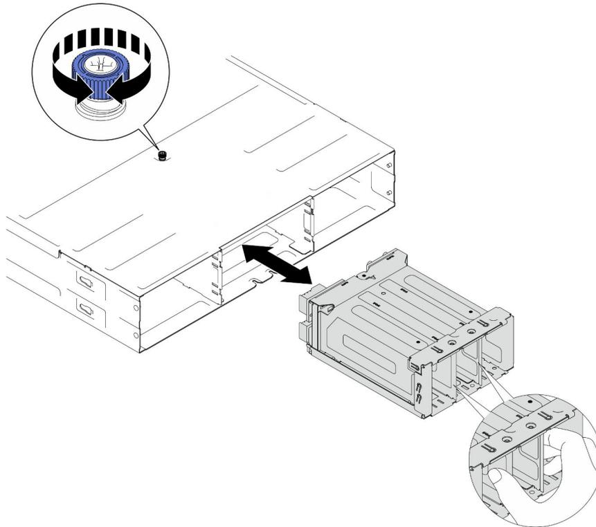
Figure 29. Installation du boîtier de PSU
