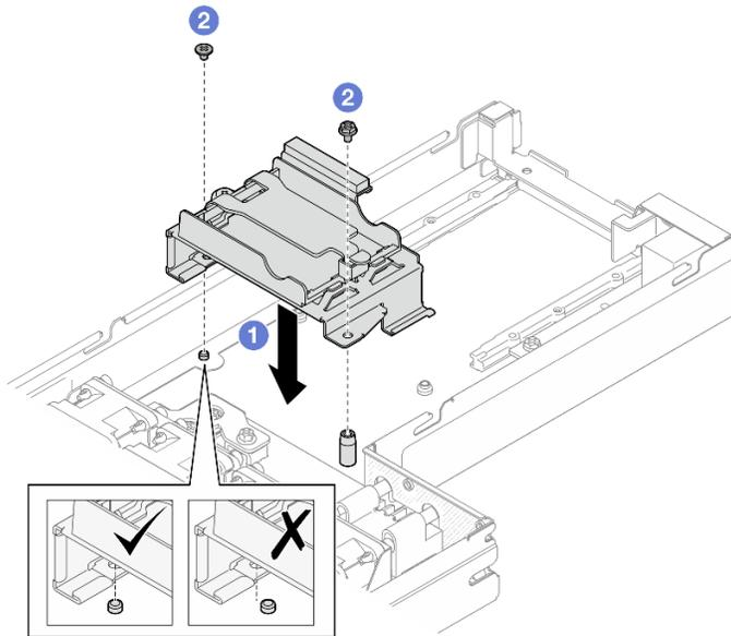
Figure 50. Installation du support du module d'alimentation flash
