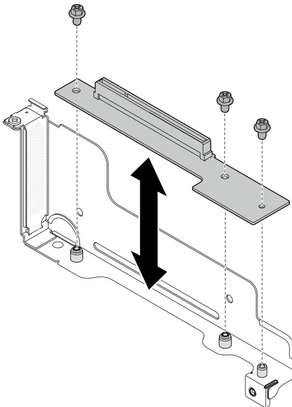
Figure 95. Remplacement de la carte mezzanine PCIe
