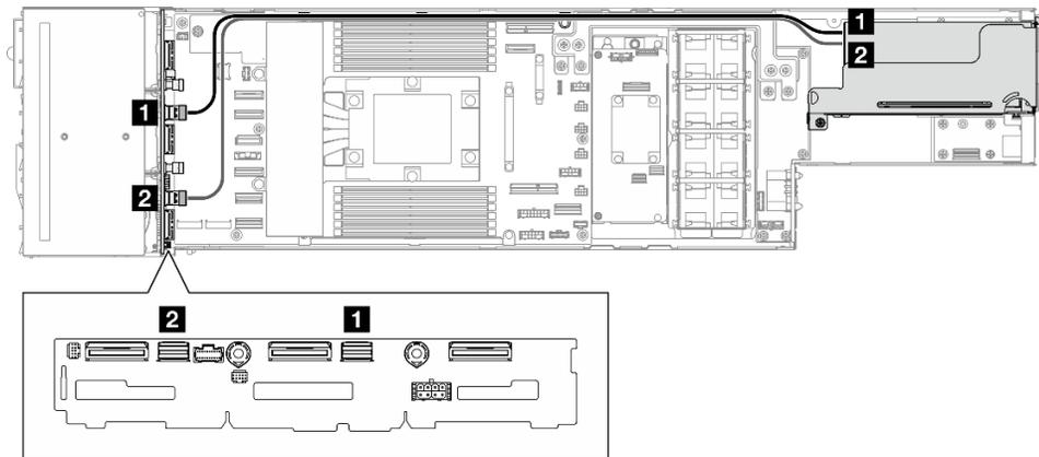
Figure 140. Cheminement des câbles SATA/SAS pour adaptateur PCIe RAID 8i
