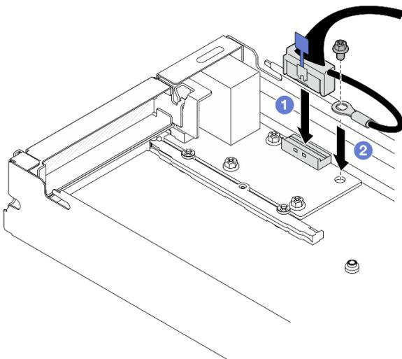
Figure 147. Installation du câble d'E-S arrière et du câble de mise à la terre
