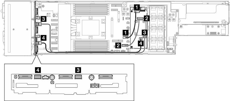
Figure 137. Cheminement des câbles RAID CFF
