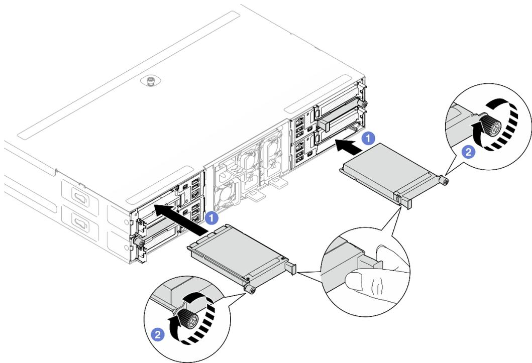
Figure 91. Installation du module OCP arrière
