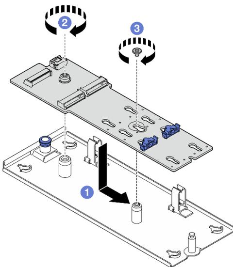
Figure 70. Installation de l'adaptateur d'amorçage M.2
