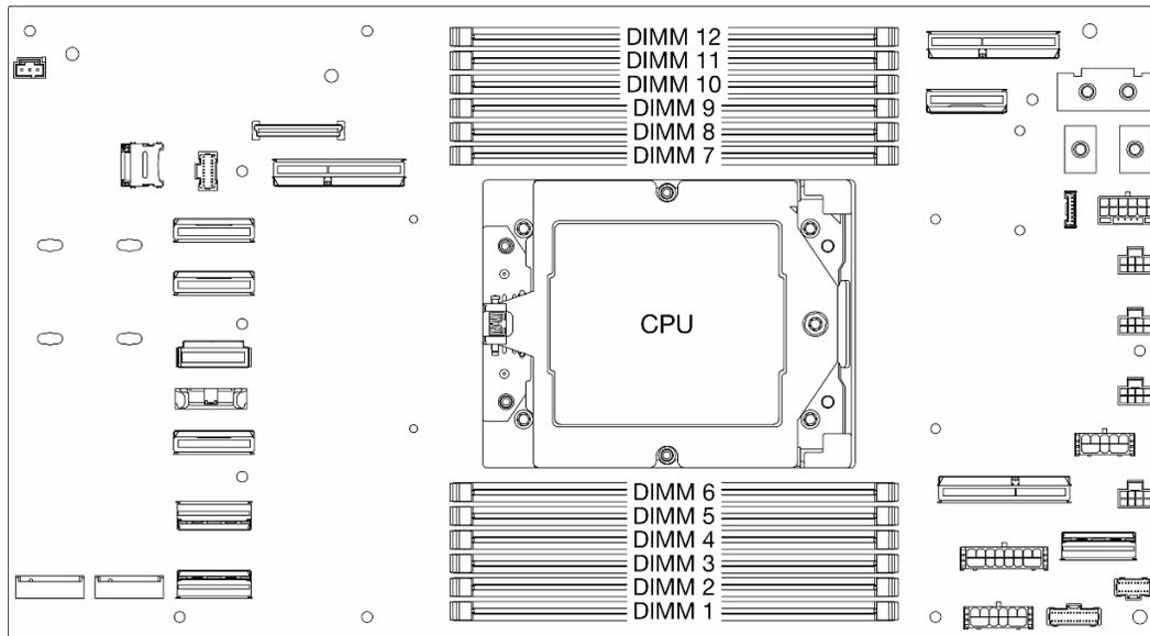
Figure 15. Disposition des modules de mémoire et des processeurs
