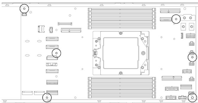
Figure 124. Installation des vis
