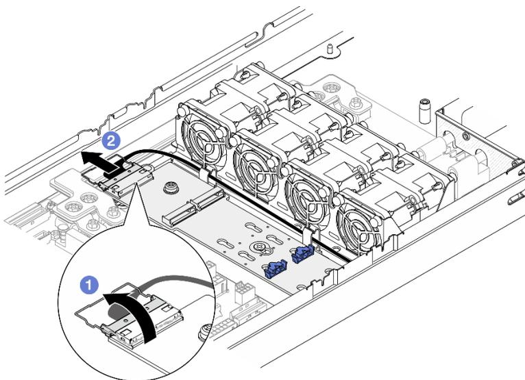
Figure 67. Déconnexion du câble de l'adaptateur d'amorçage SATA/NVMe M.2
