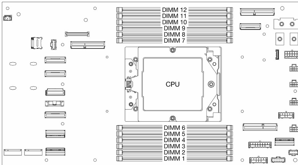
Figure 82. Disposition des modules de mémoire et des processeurs
