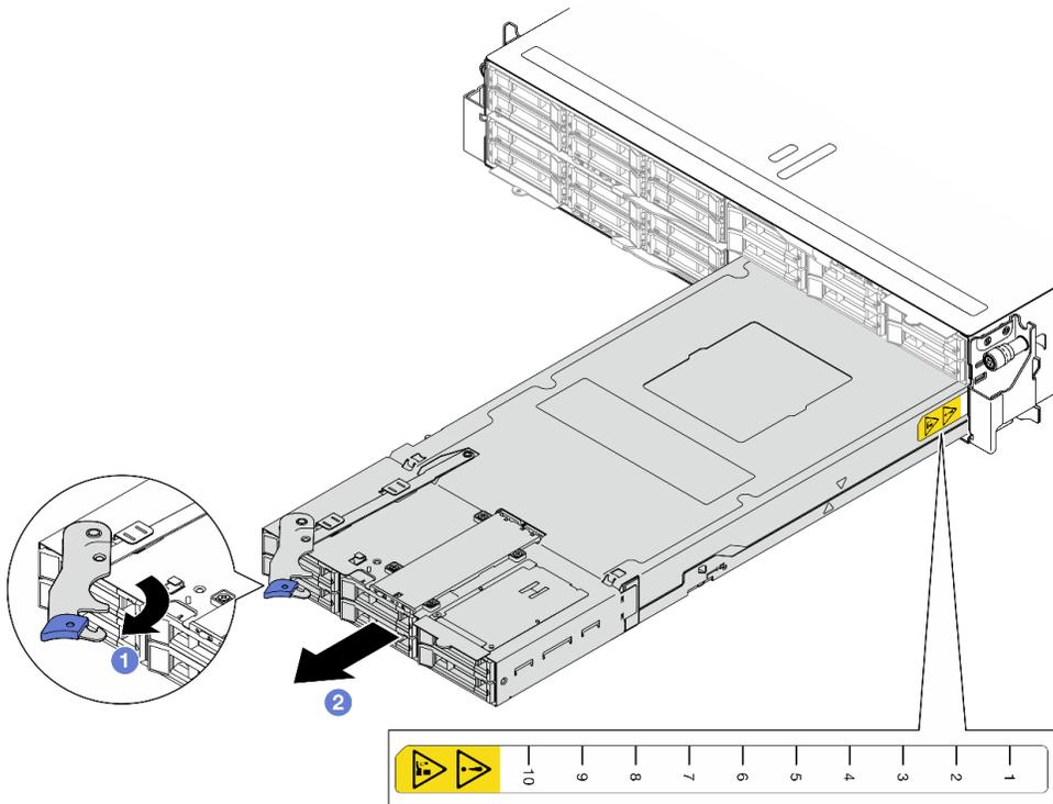
Figure 31. Retrait du nœud d'un plateau de droite
