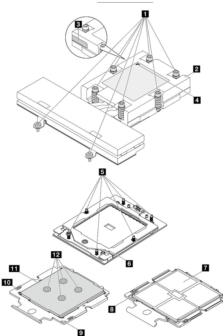
Figure 105. Composants du processeur et dissipateur thermique
