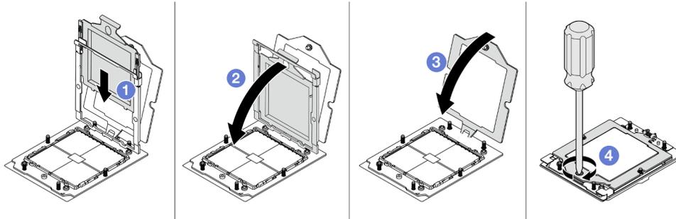
Figure 109. Installation d'un processeur
