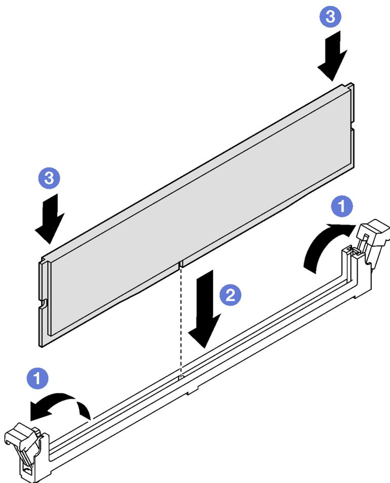
Figure 85. Installation d'un module de mémoire
