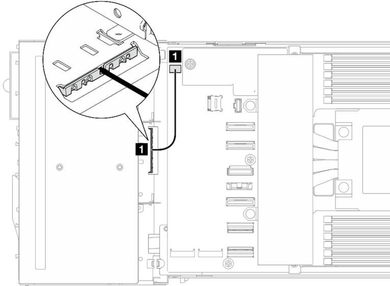
Figure 148. Cheminement des câbles du capteur thermique avant
