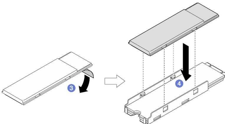
Figure 78. Installation d'un dissipateur thermique M.2 dans le plateau M.2
