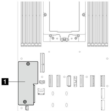
Figure 118. Emplacement du Module de microprogramme et de sécurité RoT
