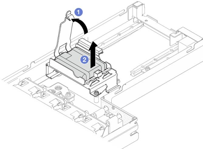
Figure 48. Retrait du module d'alimentation flash
