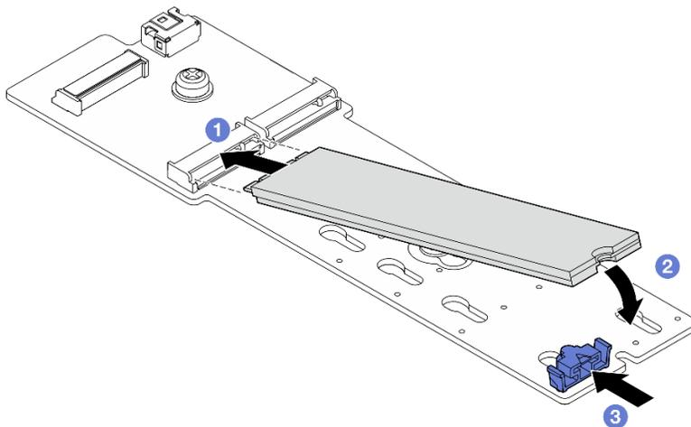
Figure 81. Installation d'une unité M.2
