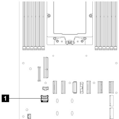
Figure 86. Emplacement du socket MicroSD
