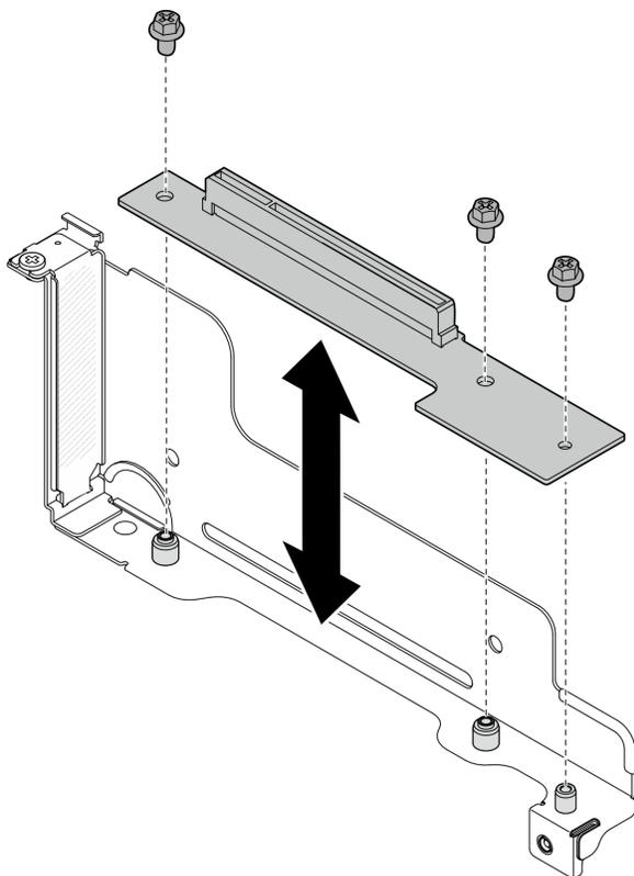
Figure 93. Remplacement de la carte mezzanine PCIe
