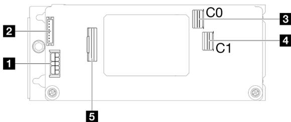
Figure 131. Connecteurs de l'adaptateur RAID CFF interne
