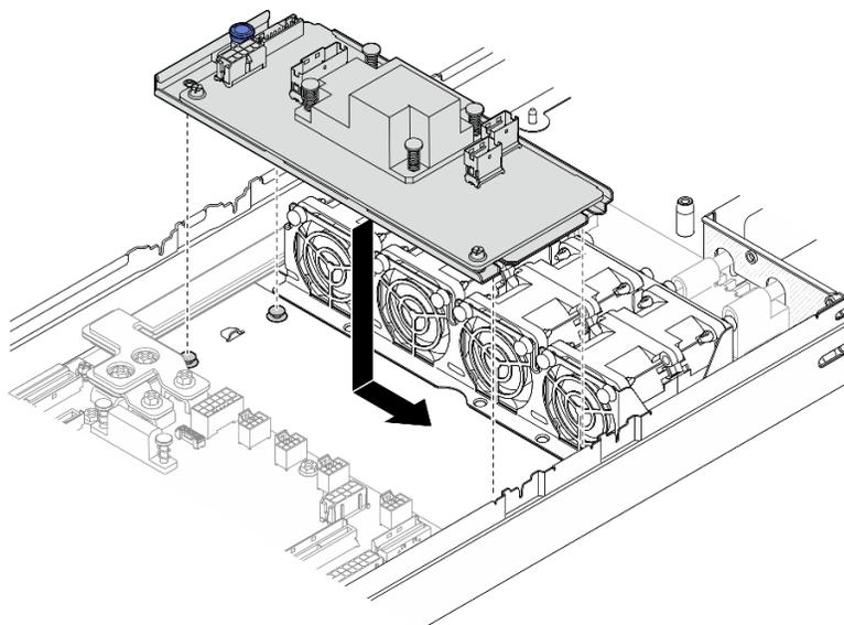
Figure 39. Installation de l'adaptateur RAID CFF interne
