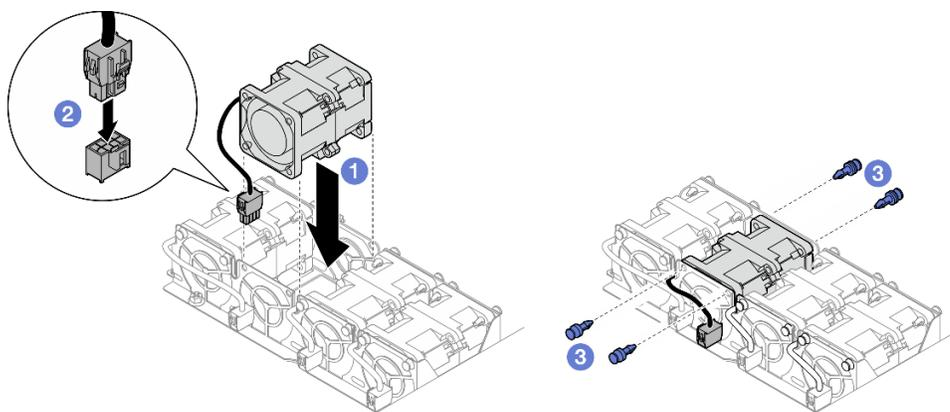
Figure 47. Installation du ventilateur
