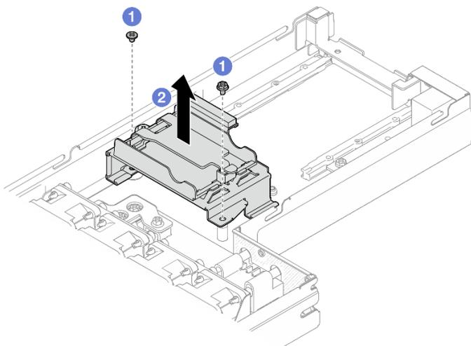
Figure 49. Retrait du support du module d'alimentation flash
