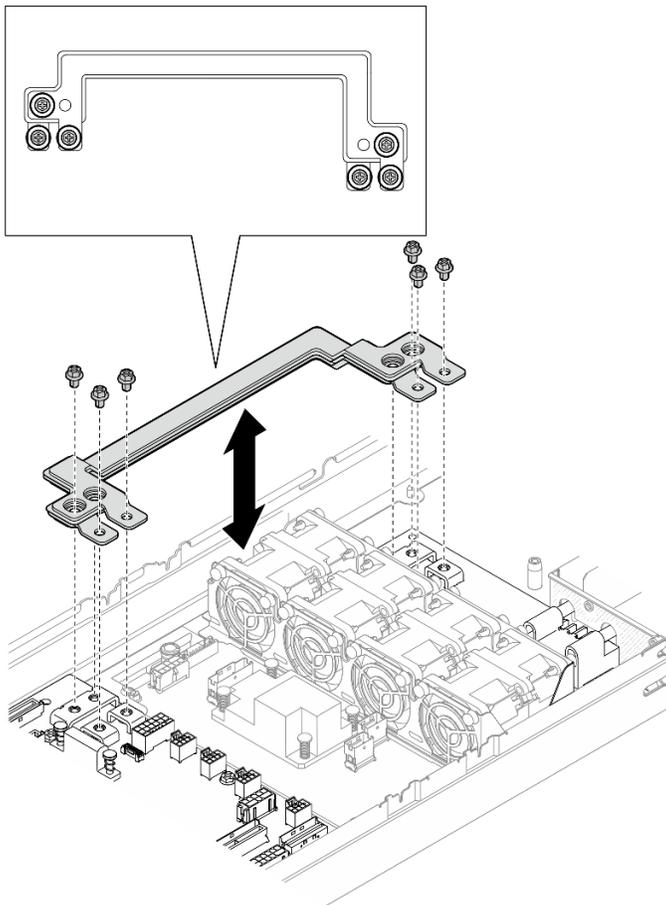
Figure 99. Retrait des vis externes de la barre-bus d'alimentation
