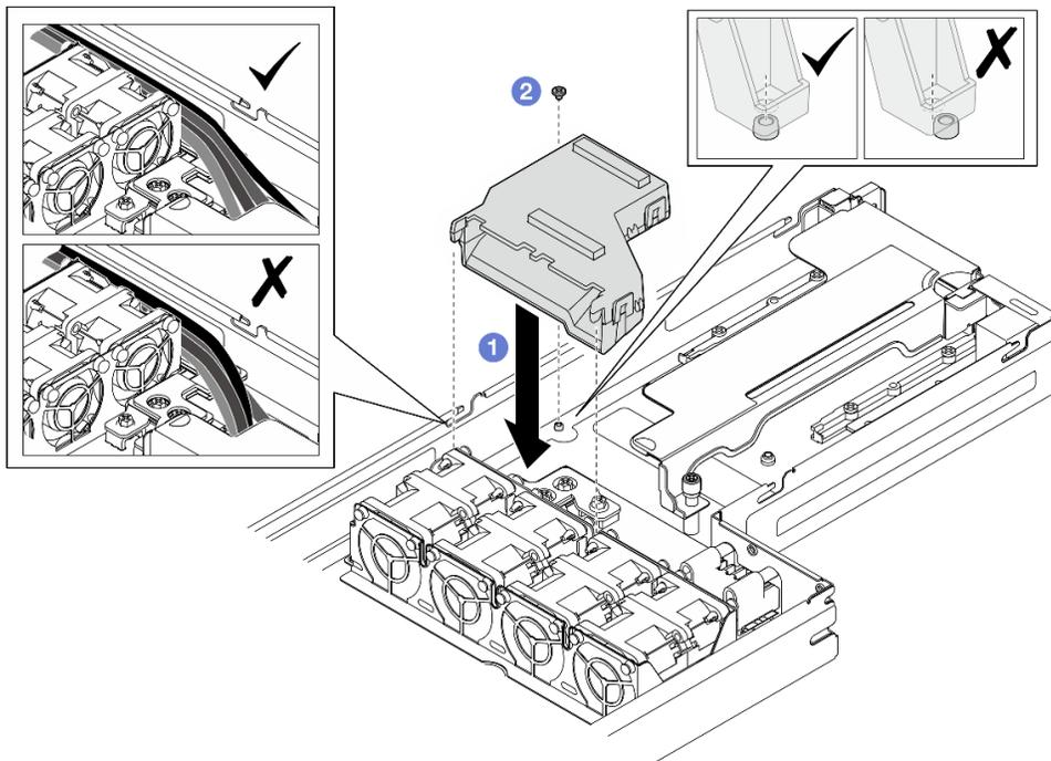
Figure 57. Installation du conduit de ventilation du GPU
