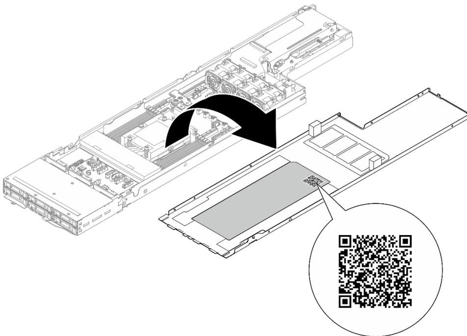
Figure 14. Étiquette de maintenance et code QR
