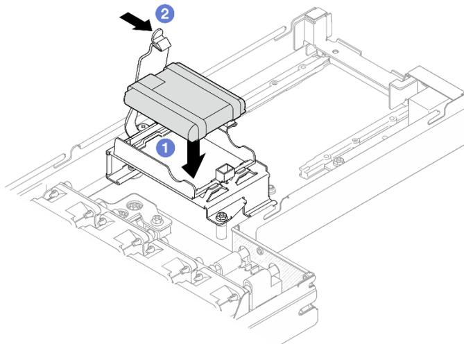
Figure 51. Installation du module d'alimentation flash
