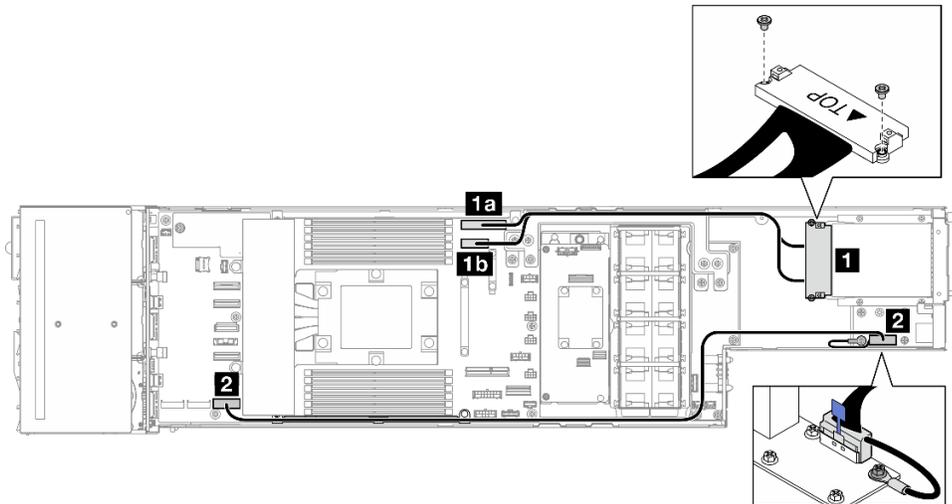
Figure 146. Câbles pour le module OCP et d'E-S arrière
