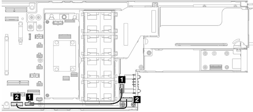
Figure 145. Cheminement des câbles pour le tableau de distribution
