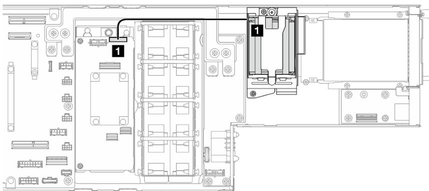
Figure 53. Câble du module d'alimentation flash et RAID CFF
