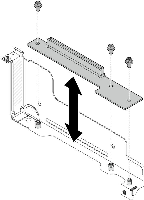
Figure 97. Remplacement de la carte mezzanine PCIe
