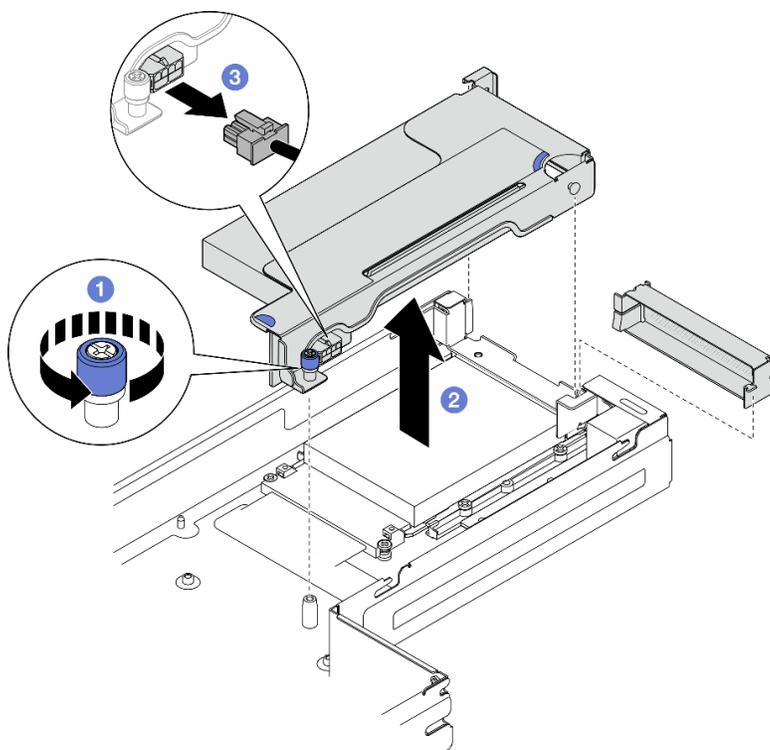
Figure 92. Retrait de l'assemblage de cartes mezzanines PCIe
