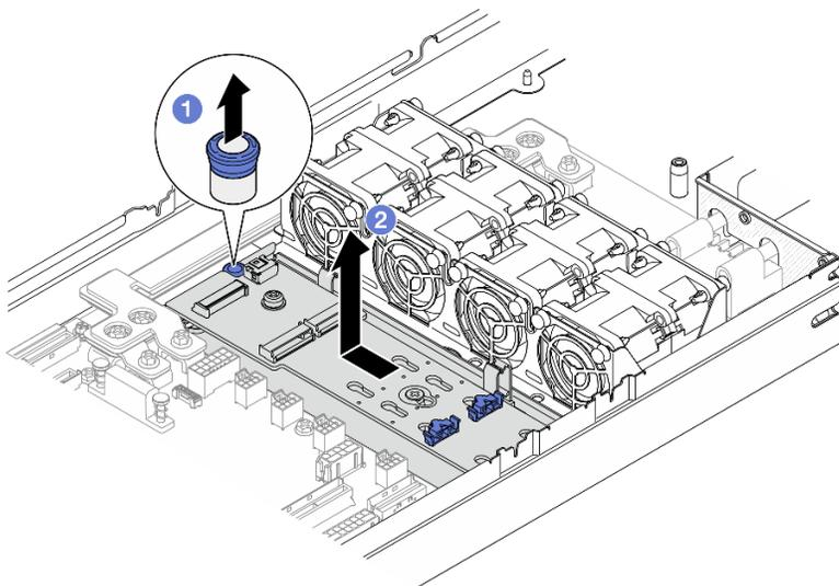
Figure 68. Retrait du plateau de l'adaptateur d'amorçage M.2
