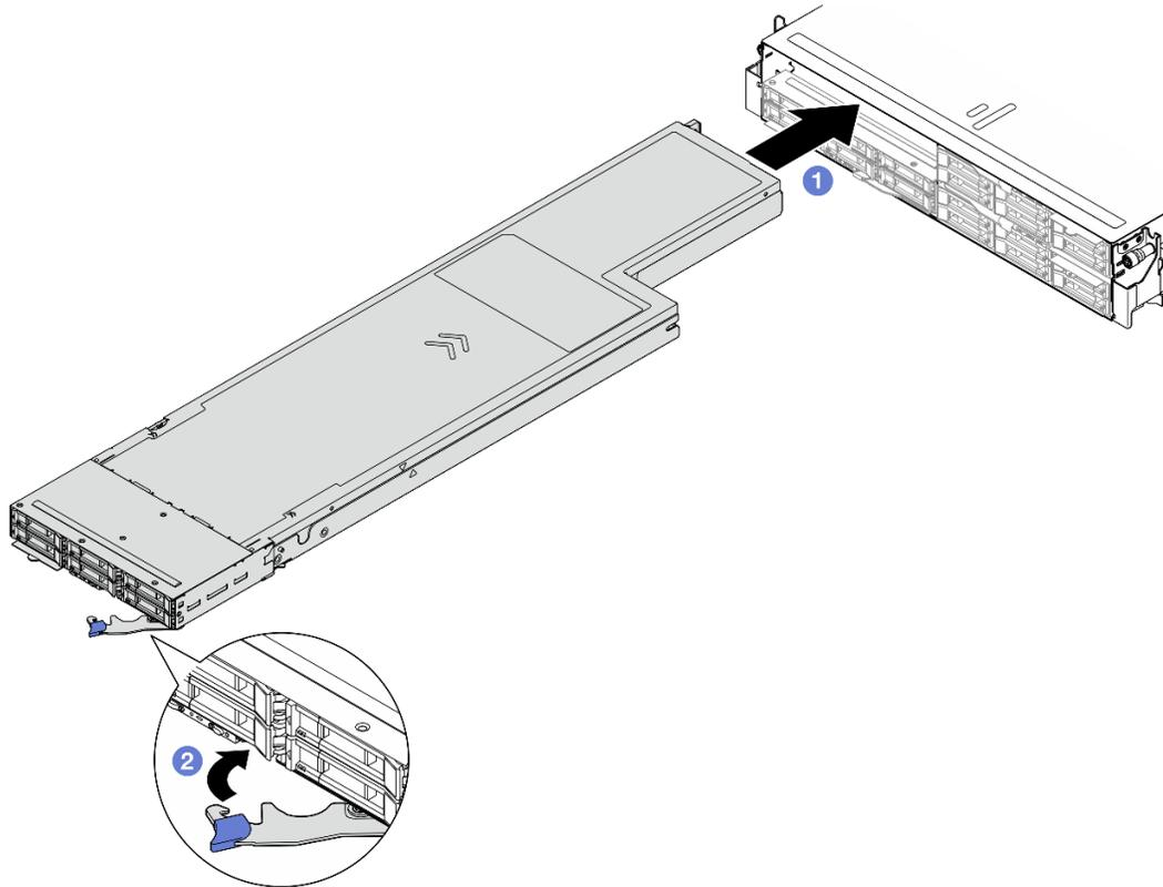
Figure 36. Installation du nœud dans un plateau de gauche
