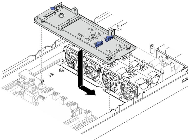
Figure 71. Installation du plateau de l'adaptateur d'amorçage M.2
