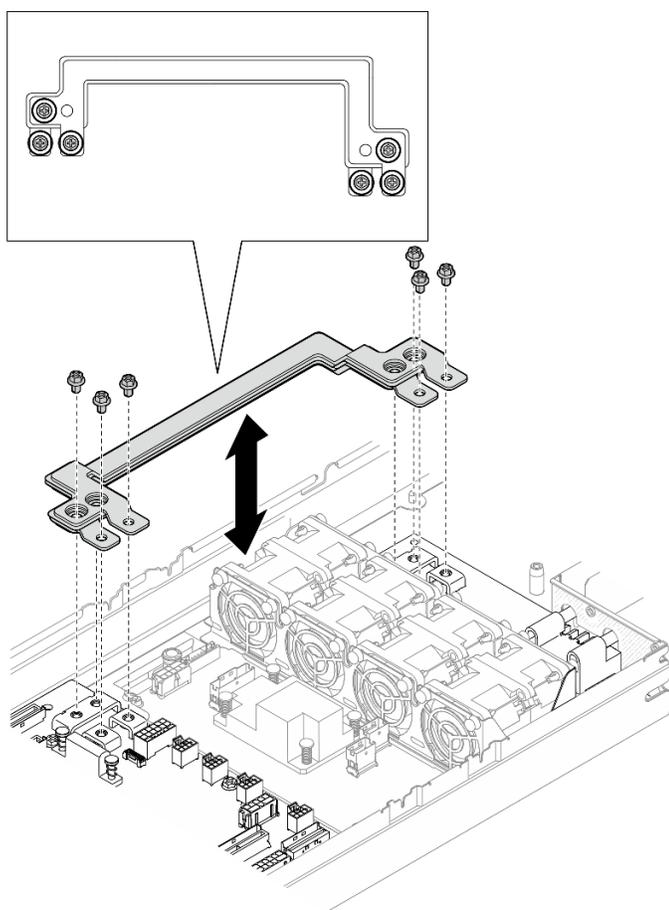
Figure 102. Installation des vis externes de la barre-bus d'alimentation
