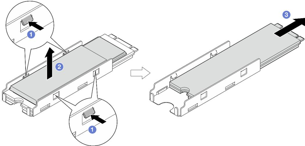
Figure 64. Retrait du dissipateur thermique M.2
