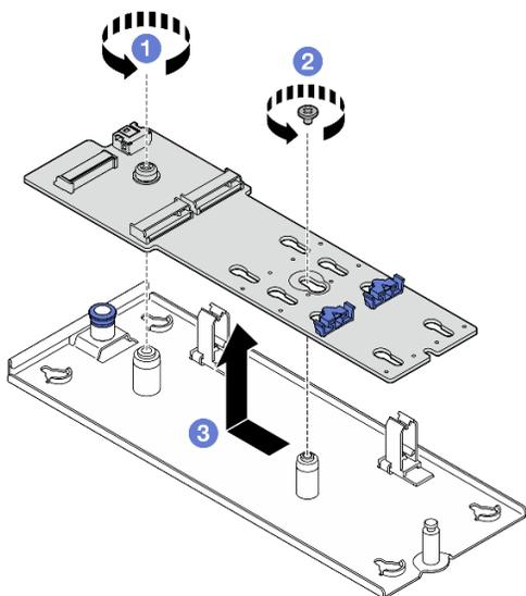
Figure 69. Retrait de l'adaptateur d'amorçage M.2
