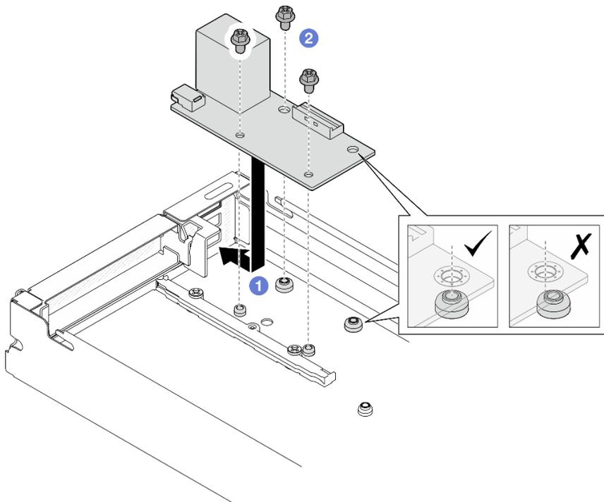
Figure 114. Installation du module d'E-S arrière
