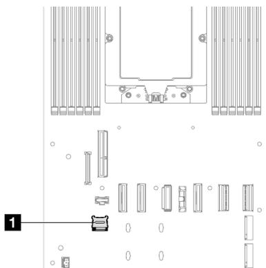
Figure 88. Emplacement du socket MicroSD
