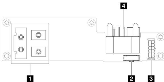
Figure 133. Connecteurs du tableau de distribution
