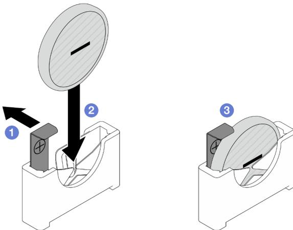
Figure 43. Installation d'une pile CMOS
