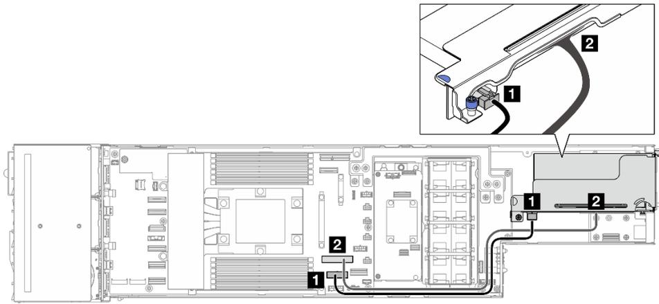
Figure 144. Cheminement des câbles de la carte mezzanine PCIe
