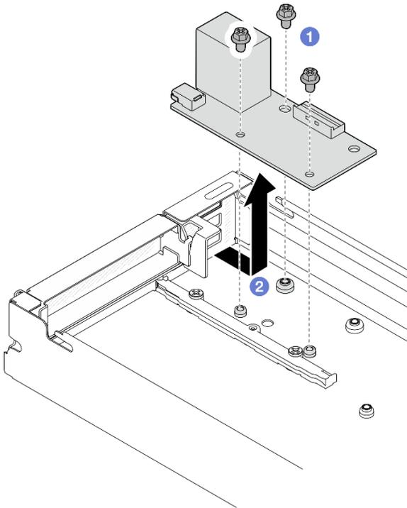
Figure 113. Retrait du module d'E-S arrière
