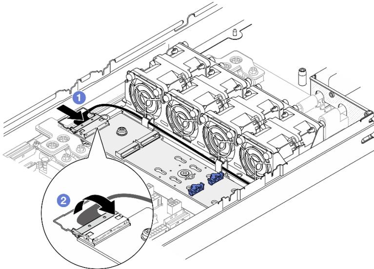
Figure 73. Connexion du câble à l'adaptateur d'amorçage SATA/NVMe M.2
