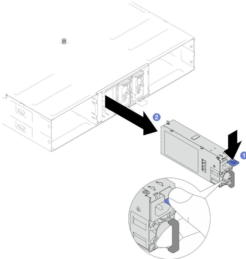
Figure 22. Retrait d'un PSU remplaçable à chaud
