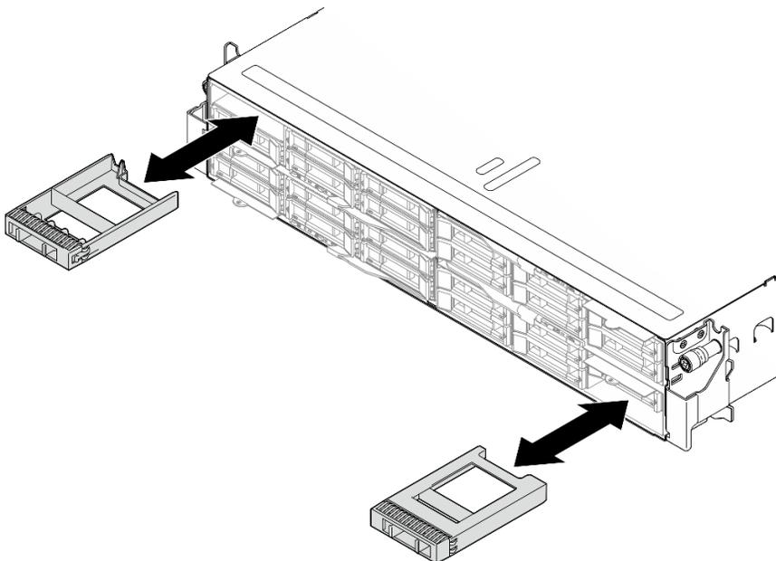
Figure 60. Remplacement d'un obturateur d'unité
