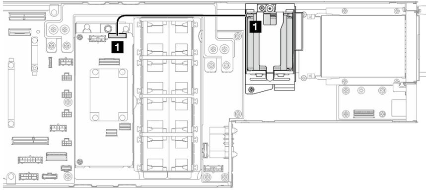
Figure 139. Cheminement du module d'alimentation flash
