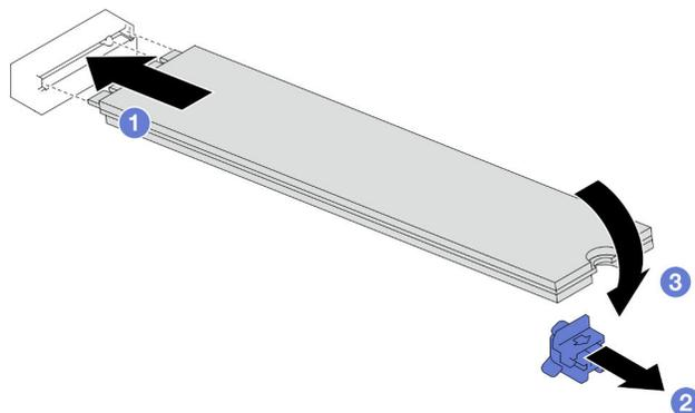
Figure 79. Installation d'une unité M.2
