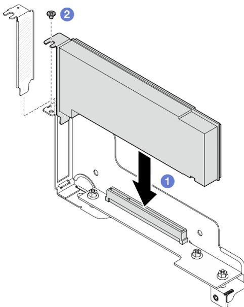
Figure 96. Installation d'un adaptateur PCIe
