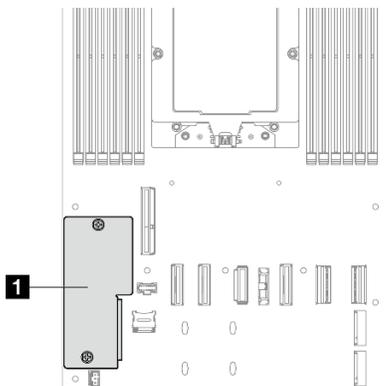
Figure 116. Emplacement du Module de microprogramme et de sécurité RoT
