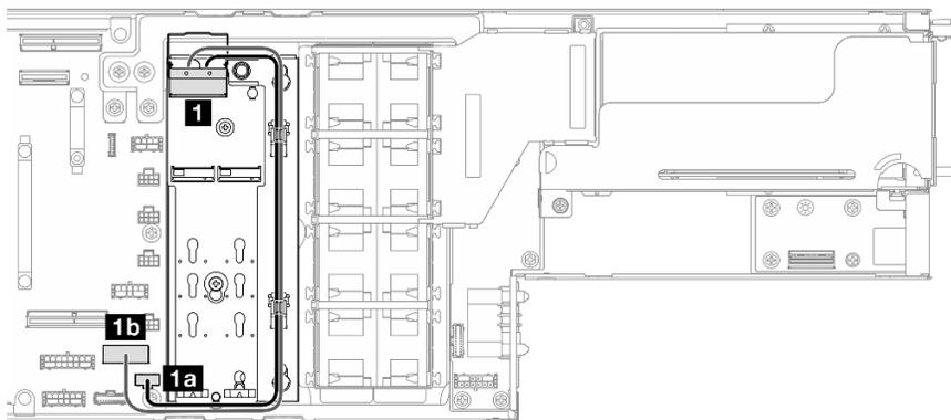
Figure 143. Cheminement des câbles pour l'adaptateur d'amorçage SATA/NVMe M.2
