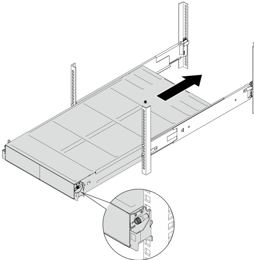
Figure 18. Installation du châssis
