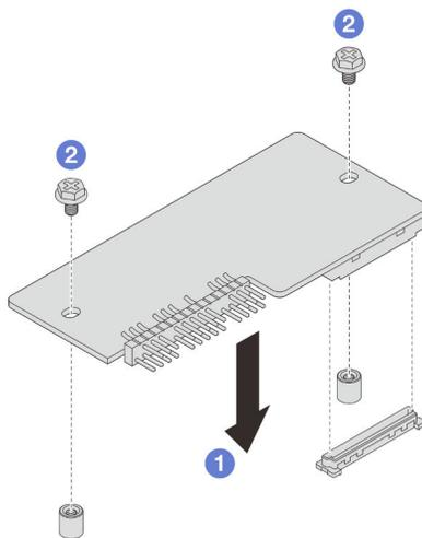
Figura 119. Installazione del modulo firmware e sicurezza RoT
