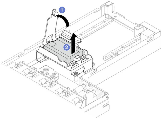
*Figura 48. Rimozione del modulo di alimentazione flash*
