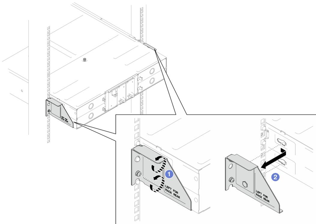
Figura 16. Rimozione delle staffe di spedizione
