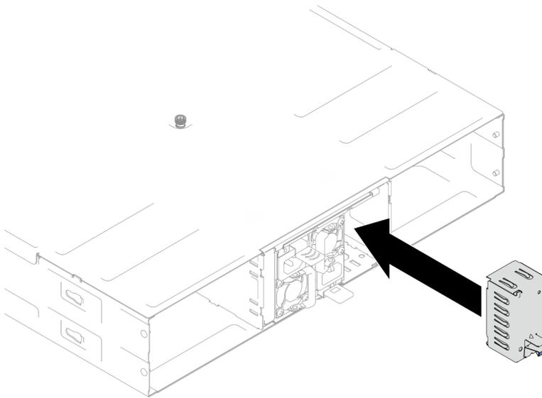
Figura 23. Installazione di un elemento di riempimento PSU
