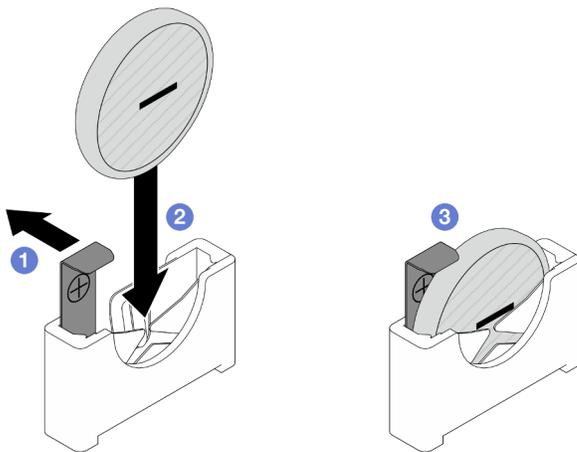
Figura 43. Installazione di una batteria CMOS
