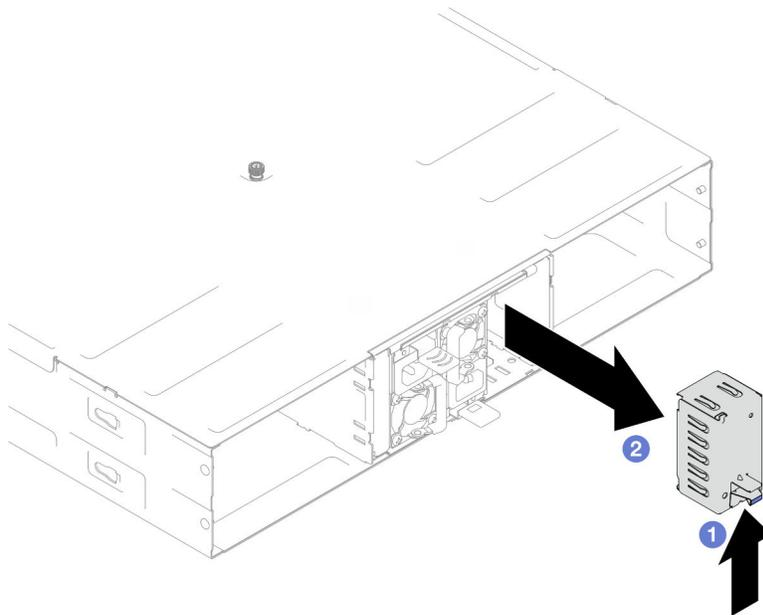
Figura 24. Rimozione di un elemento di riempimento PSU
