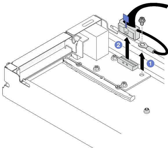
Figura 112. Rimozione del cavo I/O posteriore e del cavo di messa a terra
