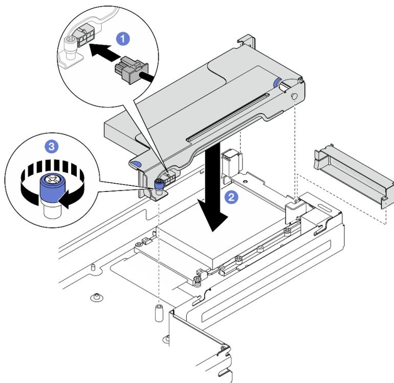
Figura 98. Installazione dell'assieme verticale PCIe
