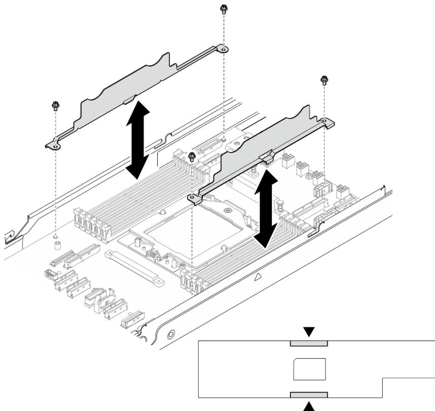
Figura 125. Sostituzione per il montaggio a parete con cavo
