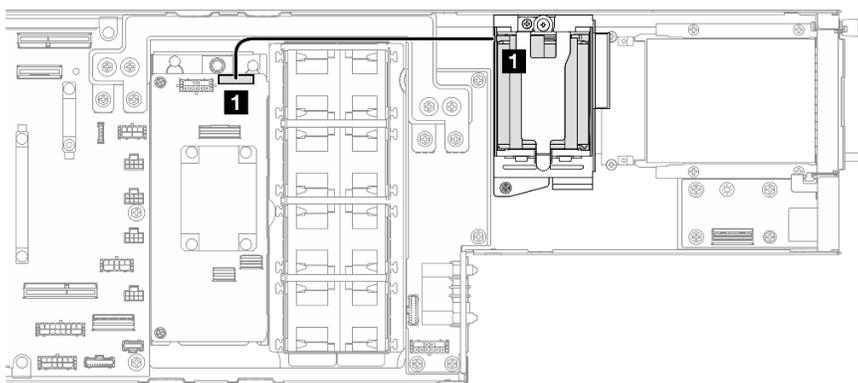
Figura 53. Cavo del modulo di alimentazione flash e RAID CFF
