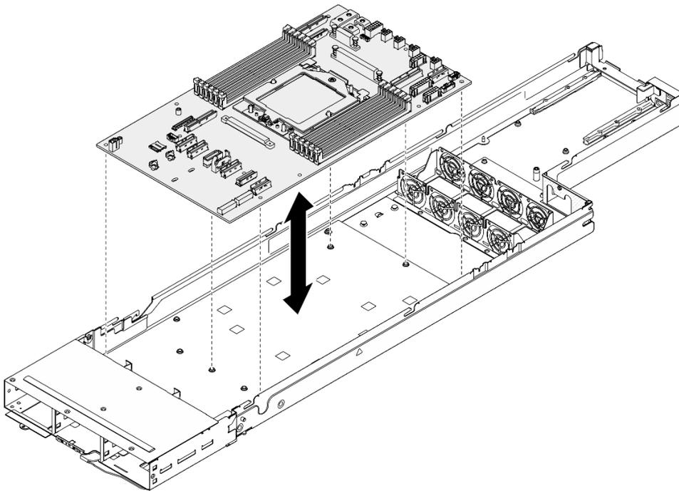
Figura 123. Installazione della scheda di sistema
