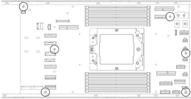
Figura 124. Installazione delle viti
