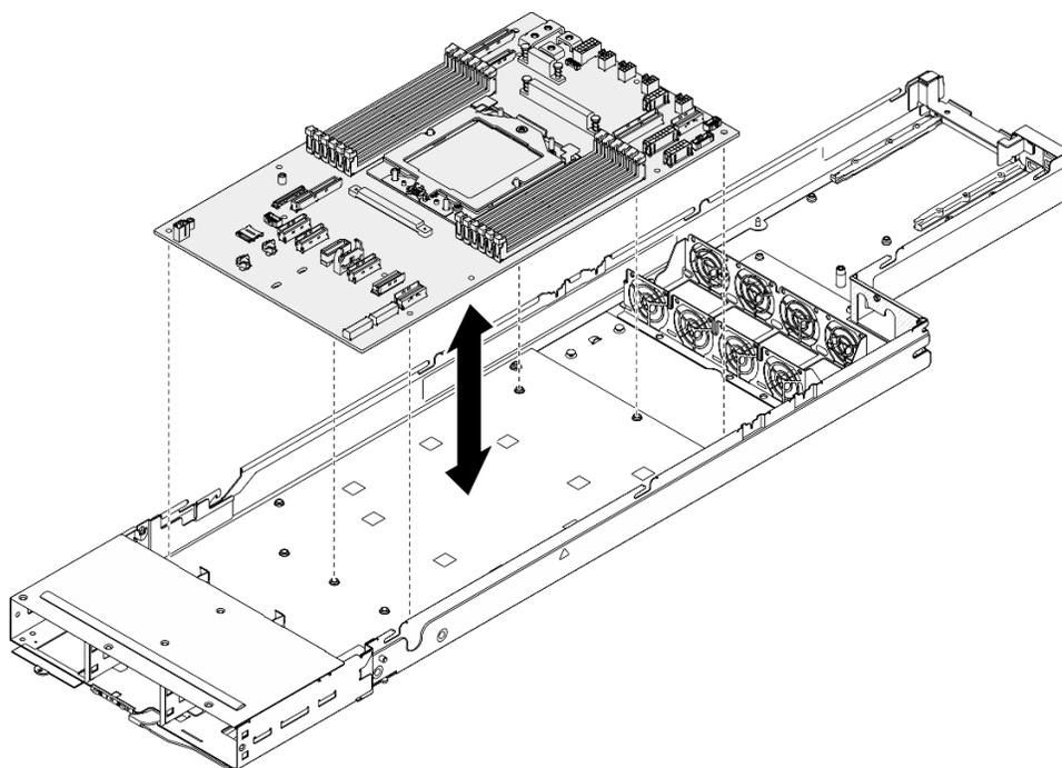
Figura 122. Rimozione della scheda di sistema
