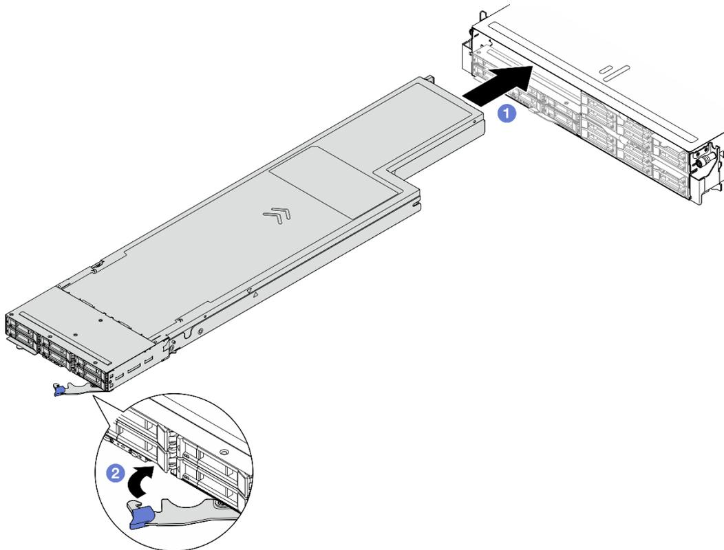
Figura 36. Installazione del nodo in un vassoio sinistro
