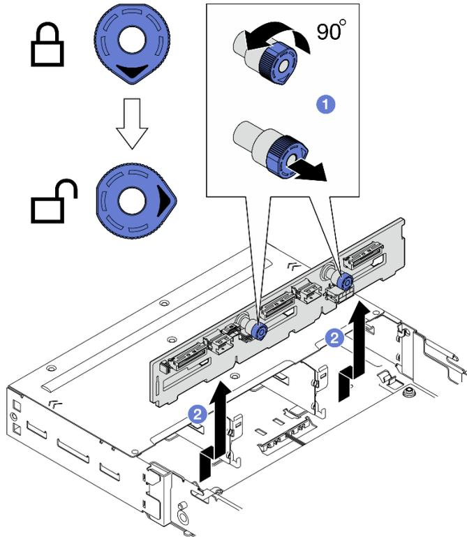
Figura 44. Rimozione del backplane dell'unità
