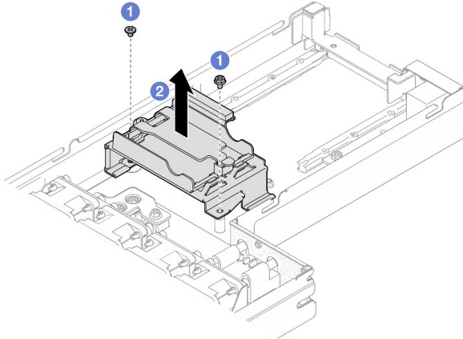
Figura 49. Rimozione del supporto del modulo di alimentazione flash
