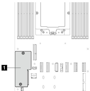
Figura 116. Posizione del Modulo firmware e sicurezza RoT
