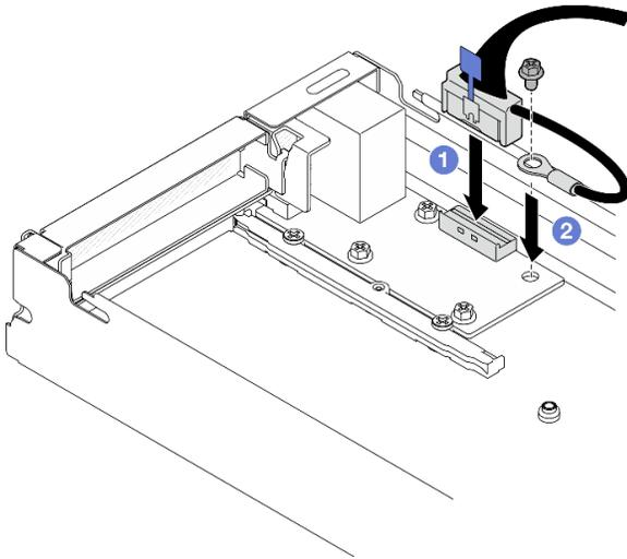
Figura 147. Installazione del cavo I/O posteriore e del cavo di messa a terra
