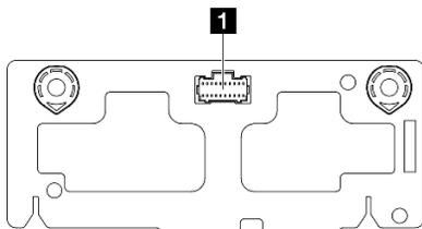
Figura 130. Connettore sulla scheda I/O anteriore
