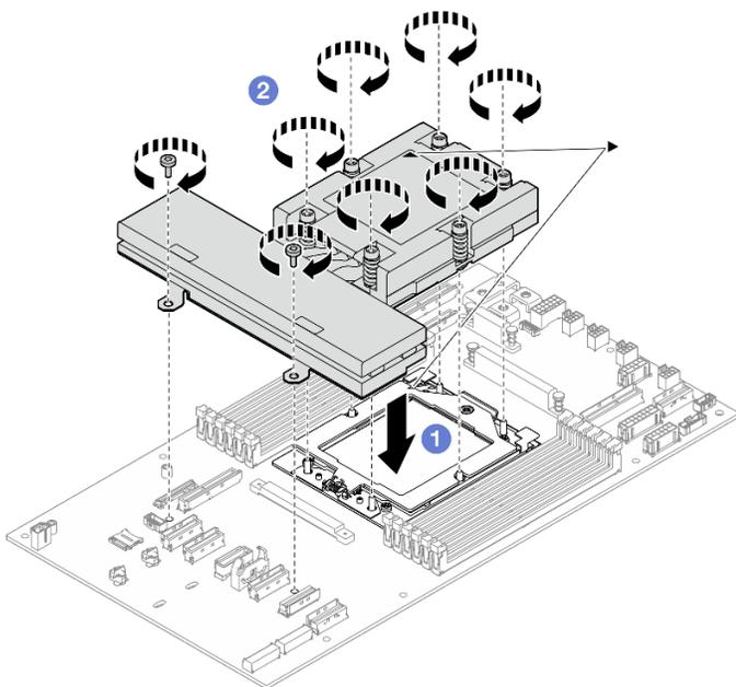
Figura 111. Installazione di un dissipatore di calore
