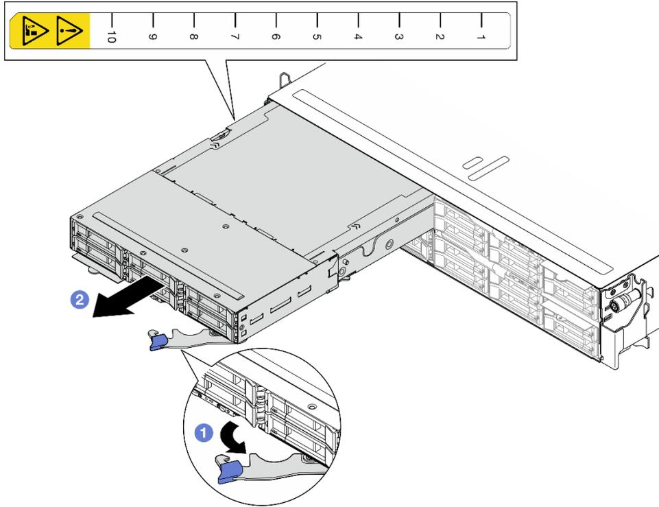
Figura 30. Rimozione del nodo da un vassoio sinistro
