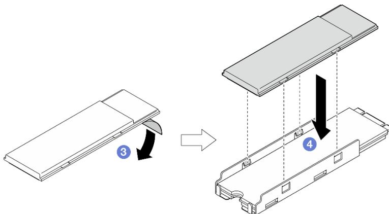
Figura 78. Installazione di un dissipatore di calore M.2 nel vassoio M.2
