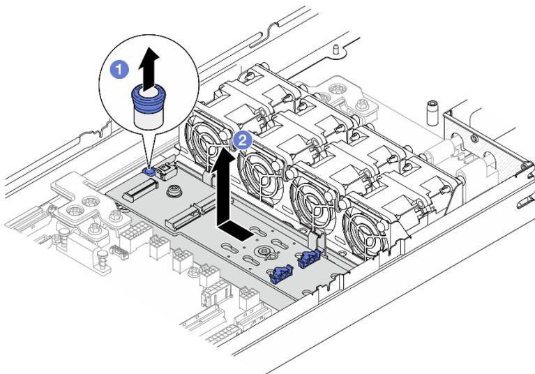
Figura 68. Rimozione del vassoio dell'adattatore di avvio M.2
