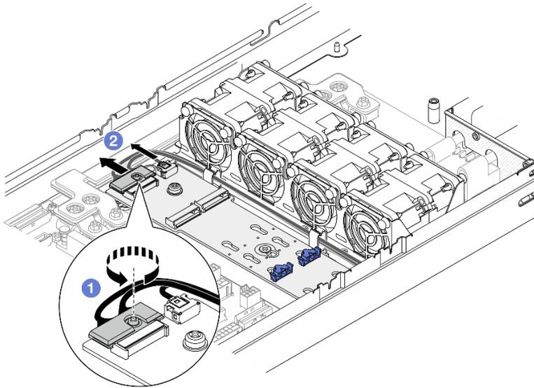
Figura 66. Scollegamento del cavo dall'adattatore di avvio M.2 NVMe
