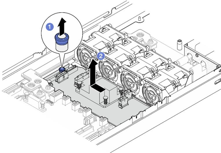
Figura 38. Rimozione dell'adattatore RAID CFF interno
