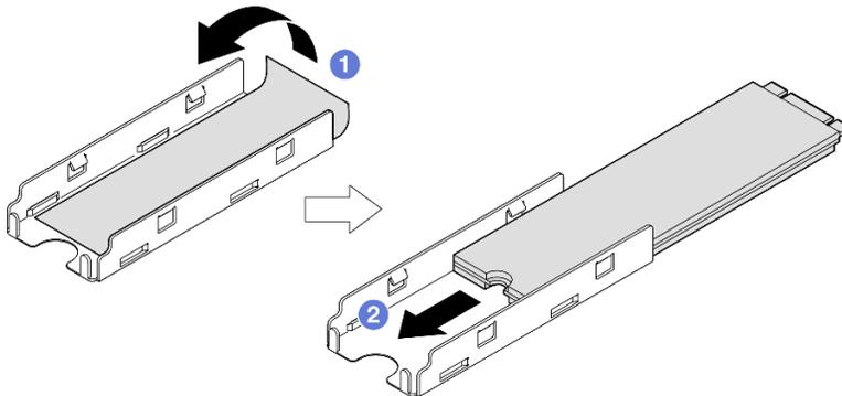
Figura 77. Installazione di un tampone termico e di un'unità M.2 nel vassoio
