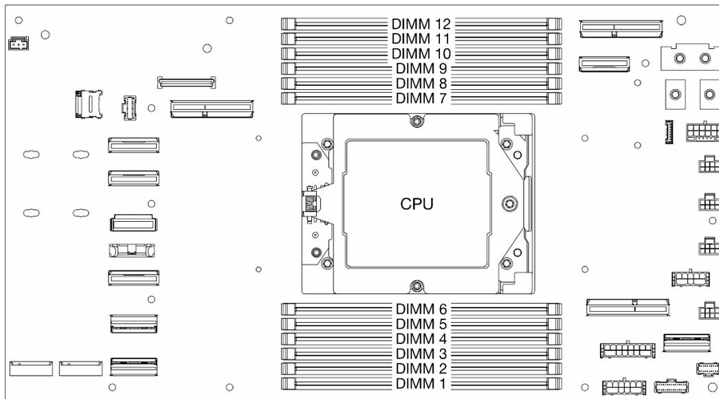
Figura 15. Layout dei moduli di memoria e del processore
