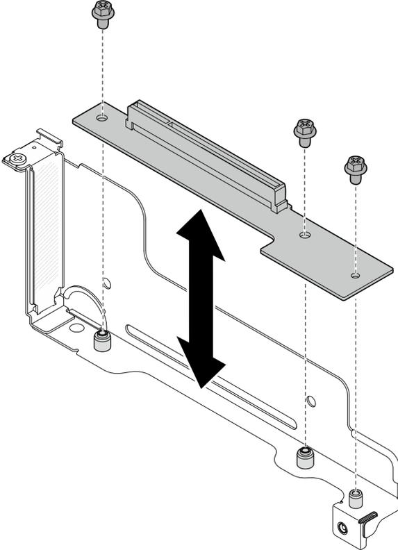
Figura 97. Sostituzione della scheda verticale PCIe
