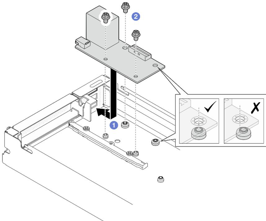
Figura 114. Installazione del modulo I/O posteriore
