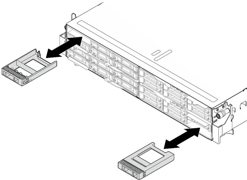
Figura 59. Sostituzione di un elemento di riempimento dell'unità
