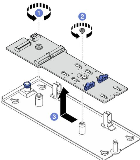
Figura 69. Rimozione dell'adattatore di avvio M.2
