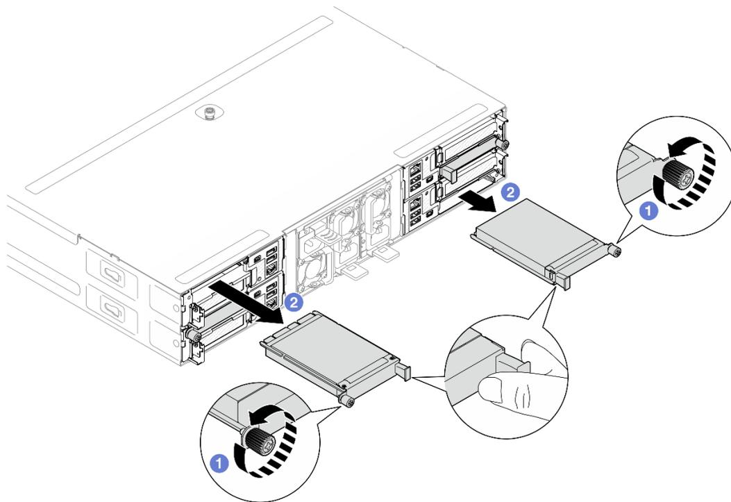
Figura 90. Rimozione del modulo OCP posteriore
