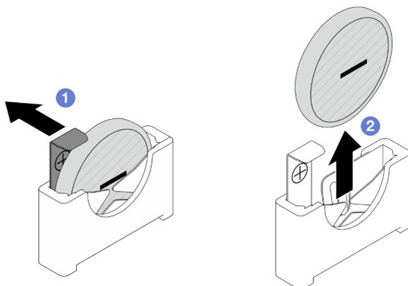
Figura 41. Rimozione della batteria CMOS
