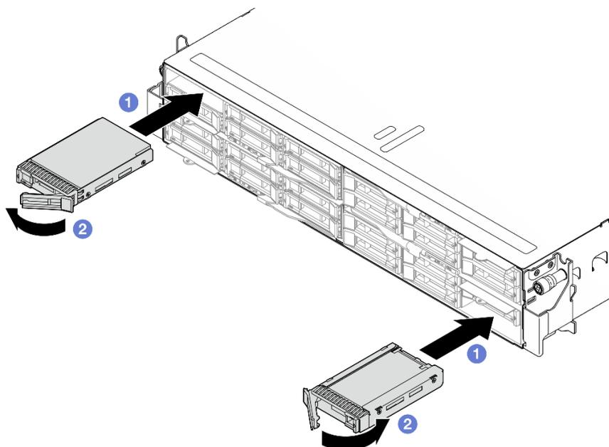
Figura 61. Installazione di un'unità SSD
