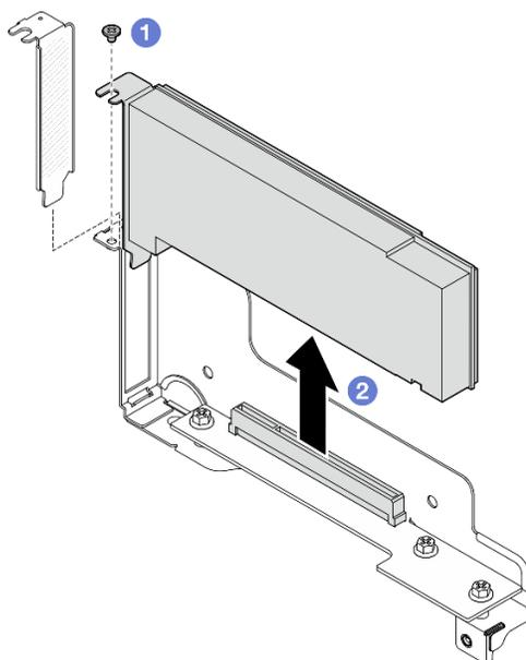
Figura 94. Rimozione di un adattatore PCIe
