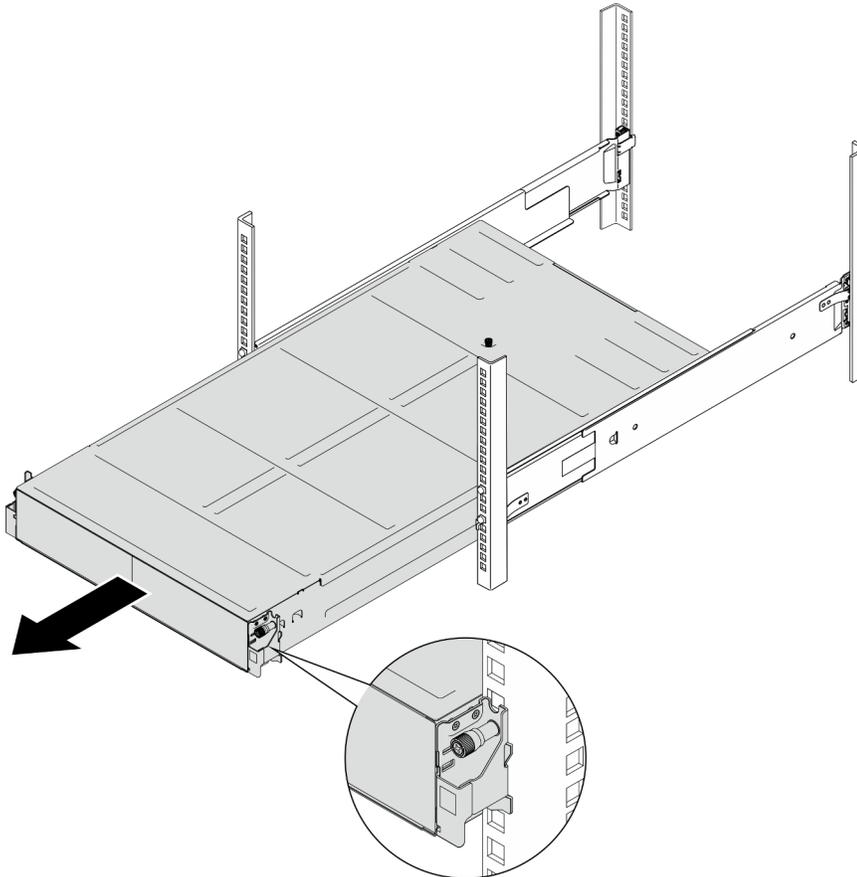
Figura 17. Rimozione dello chassis
