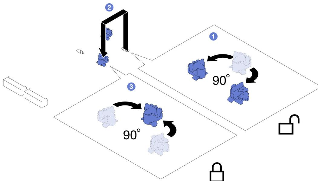
Figura 74. Regolazione del fermo di un'unità M.2
