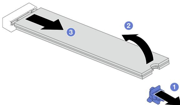
*Figura 63. Rimozione di un'unità M.2*
