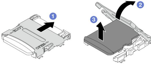
Figura 87. Rimozione della scheda MicroSD
