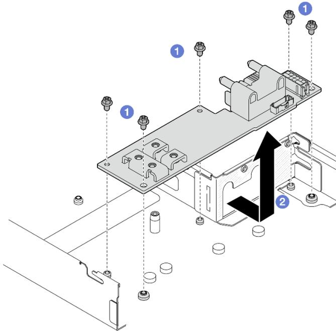
Figura 103. Rimozione della scheda di distribuzione dell'alimentazione
