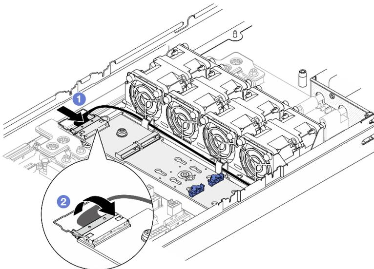
Figura 73. Collegamento del cavo all'adattatore di avvio M.2 SATA/NVMe
