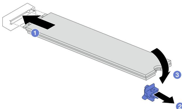
Figura 79. Installazione di un'unità M.2
