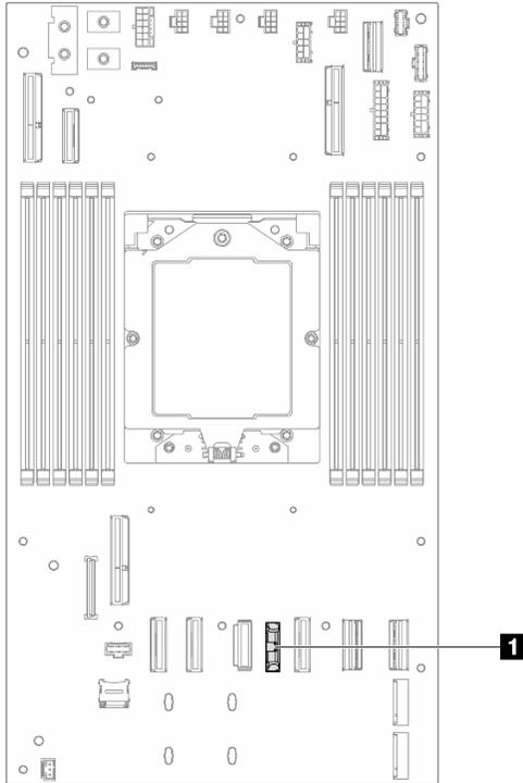
*Figura 40. Posizione del socket della batteria CMOS*
