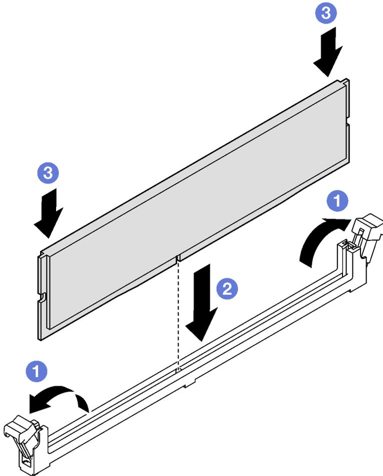
Figura 85. Installazione di un modulo di memoria
