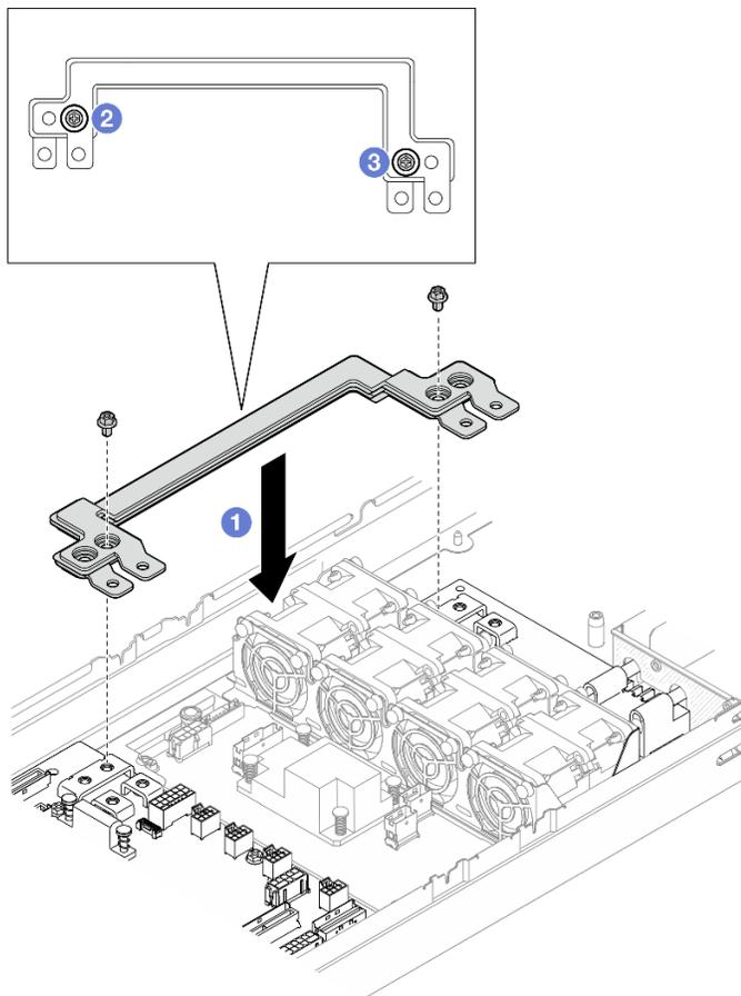
Figura 101. Installazione della barra del bus di alimentazione
