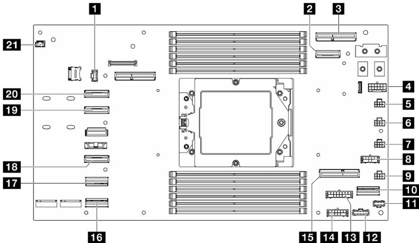
Figura 128. Connettori della scheda di sistema per l'instradamento dei cavi
