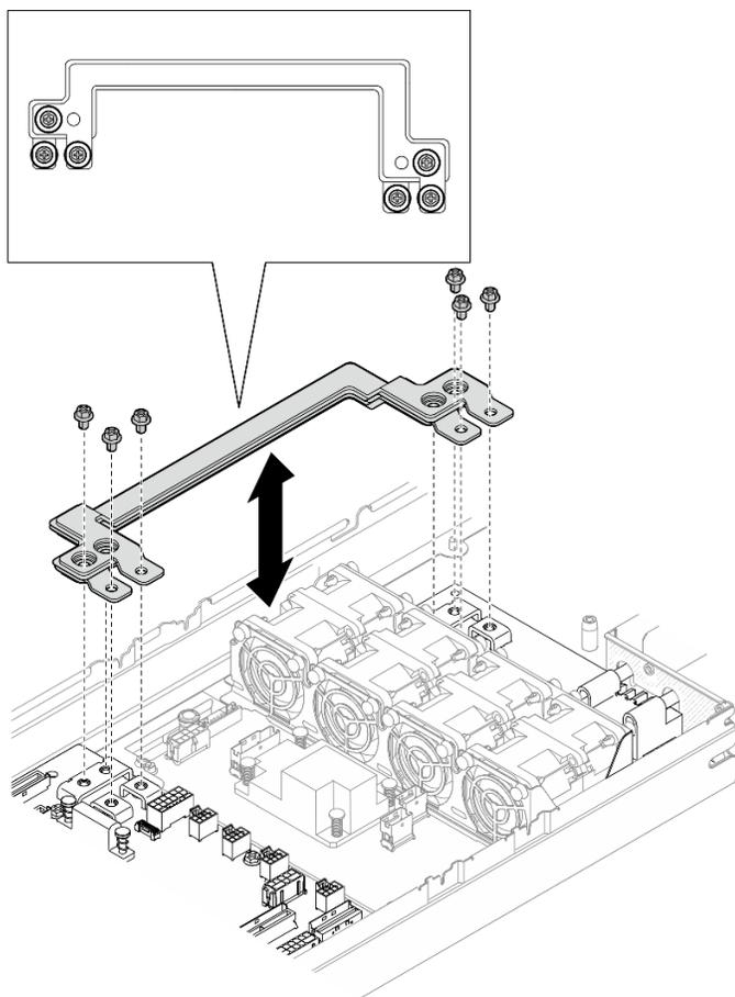
Figura 102. Installazione delle viti della barra del bus di alimentazione
