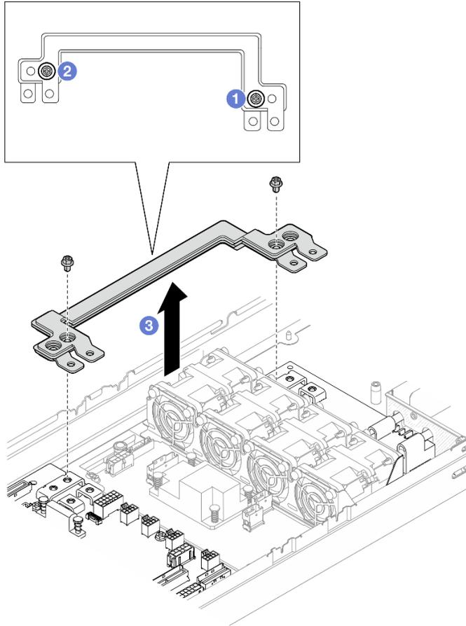
Figura 100. Rimozione della barra del bus di alimentazione
