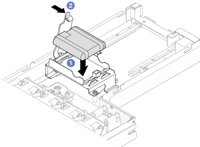
Figura 51. Installazione del modulo di alimentazione flash
