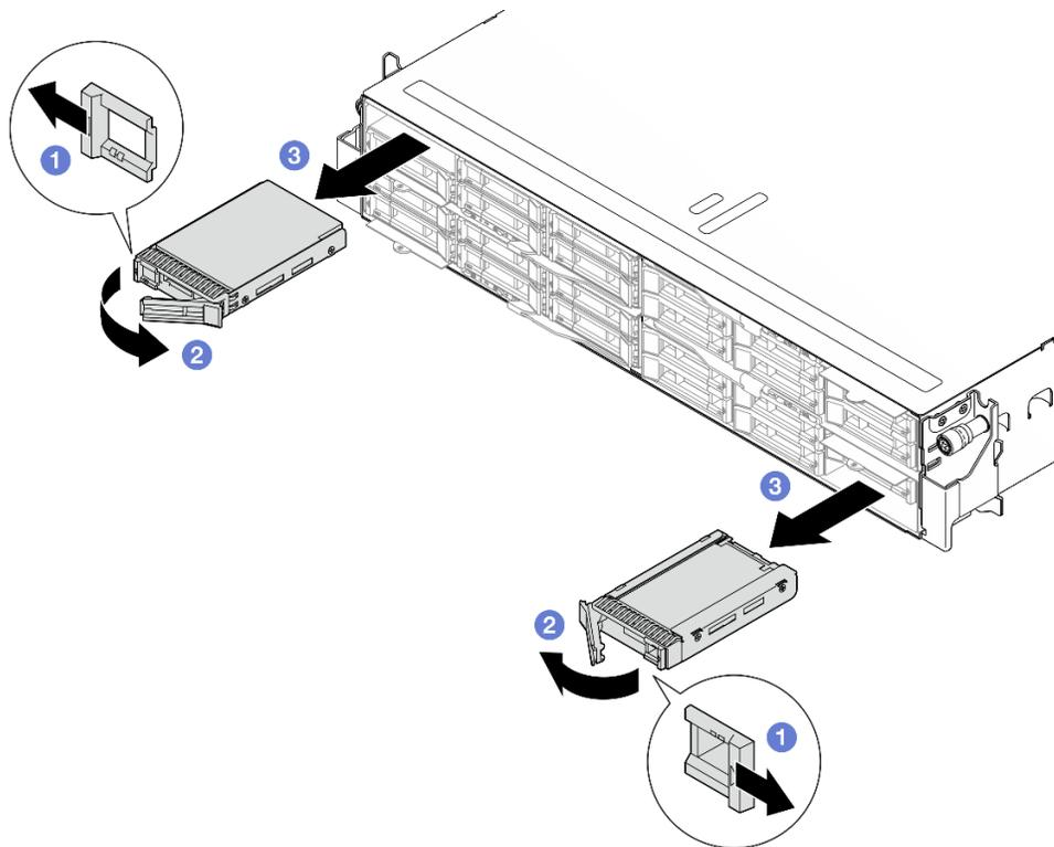
Figura 58. Rimozione di un'unità SSD
