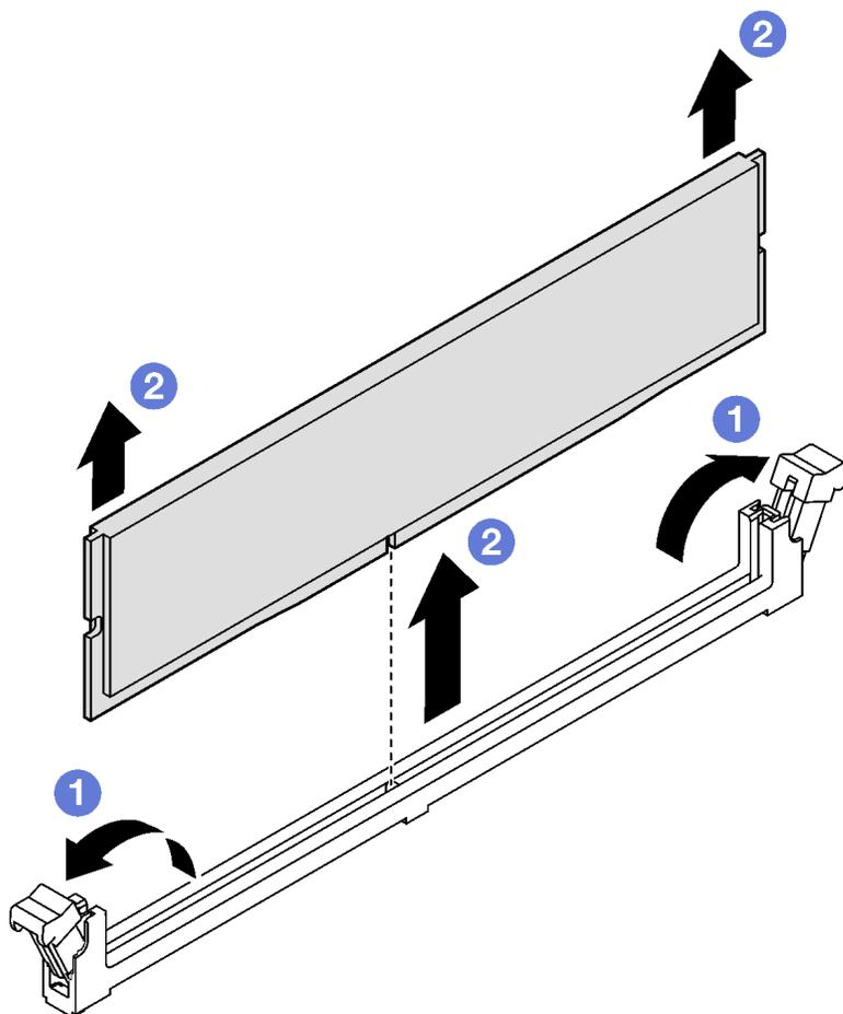
Figura 83. Rimozione di un modulo di memoria
