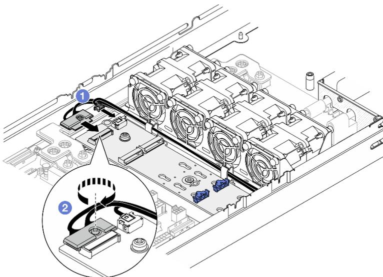
Figura 72. Collegamento del cavo all'adattatore di avvio M.2 NVMe
