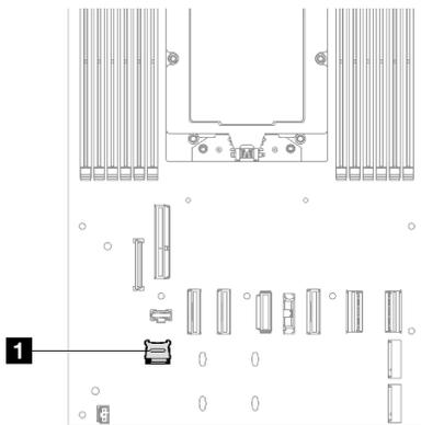
Figura 88. Posizione del socket MicroSD
