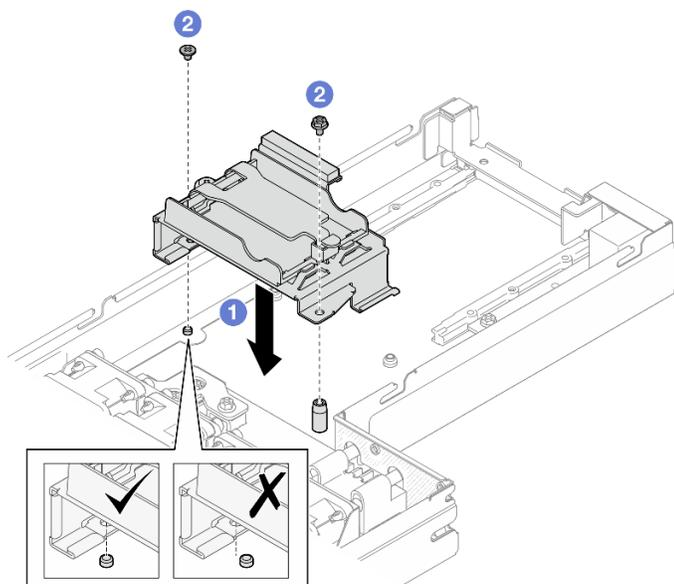
Figura 50. Installazione del supporto del modulo di alimentazione flash
