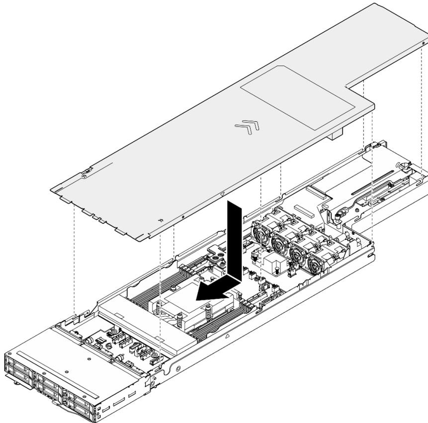
Figura 127. Installazione del coperchio superiore
