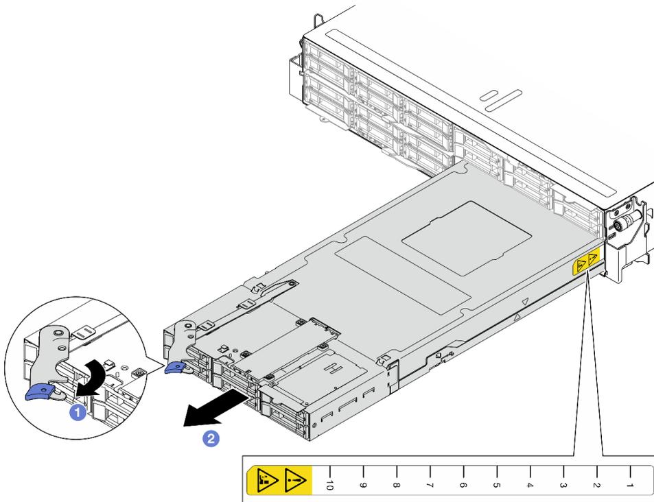
Figura 31. Rimozione del nodo da un vassoio destro
