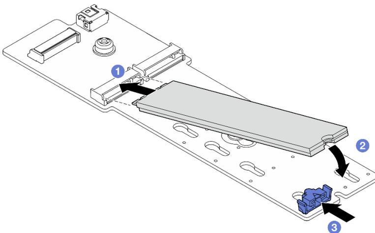
Figura 81. Installazione di un'unità M.2
