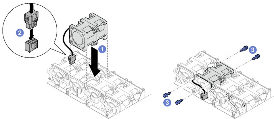
Figura 47. Installazione delle ventole
