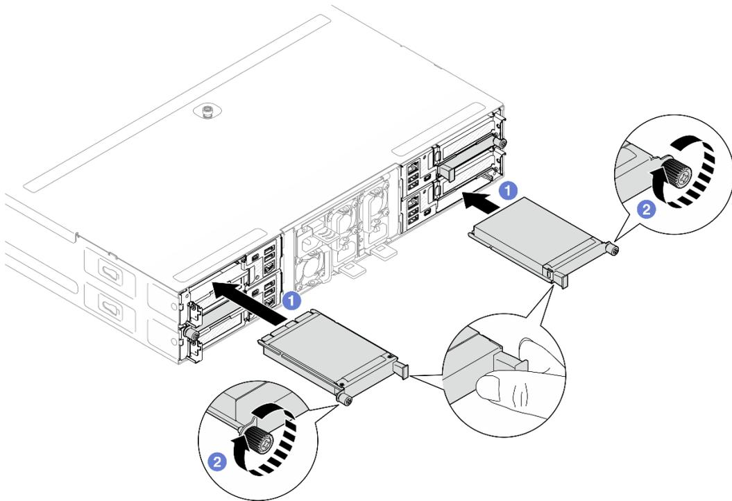
Figura 91. Installazione del modulo OCP posteriore
