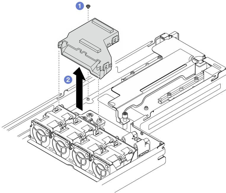
Figura 56. Rimozione del condotto dell'aria GPU
