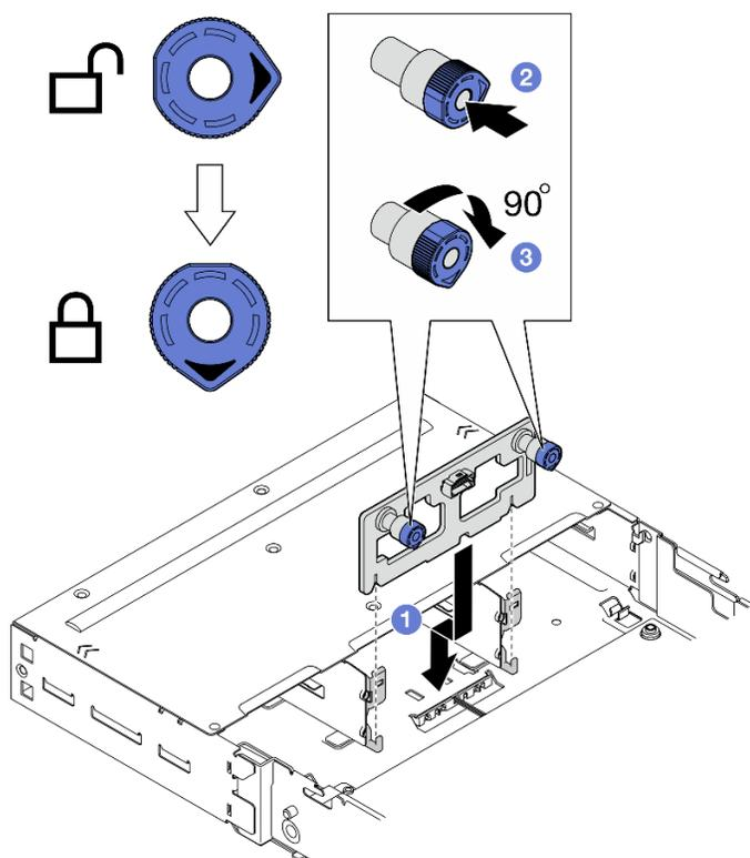
Figura 55. Installazione del backplane I/O anteriore
