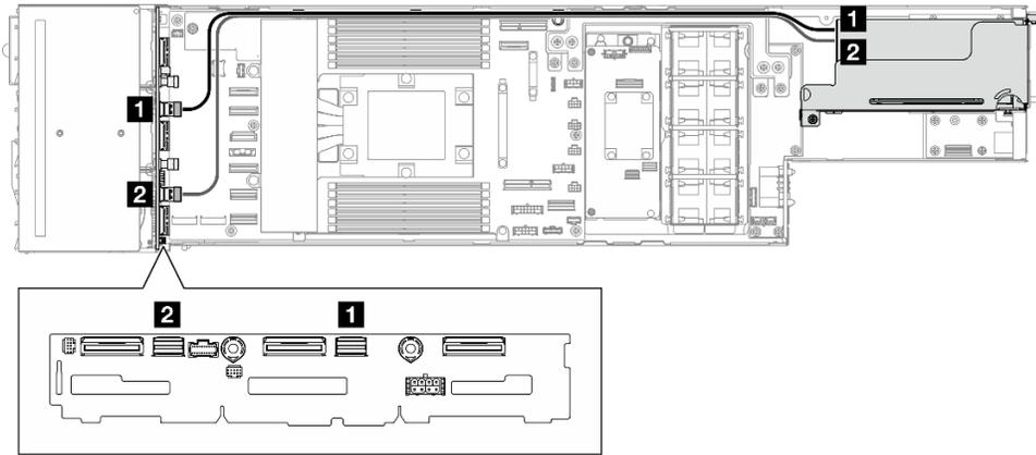
Figura 140. Instradamento dei cavi SATA/SAS per l'adattatore PCIe RAID 8i
