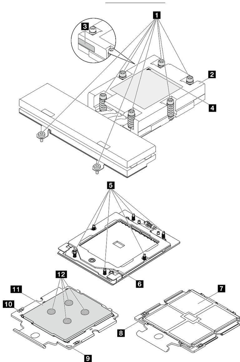
Figura 108. Componenti del processore e del dissipatore di calore
