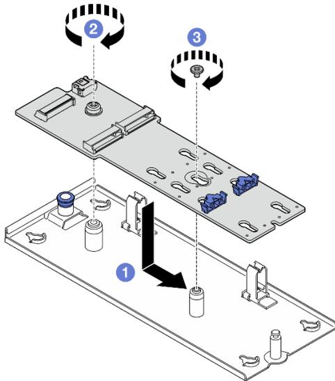
Figura 70. Installazione dell'adattatore di avvio M.2
