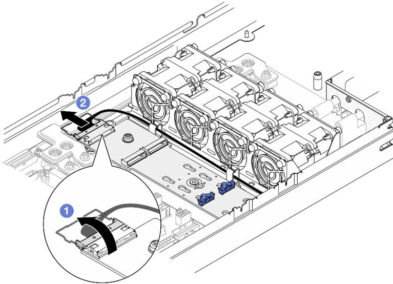
Figura 67. Scollegamento del cavo dall'adattatore di avvio M.2 SATA/NVMe
