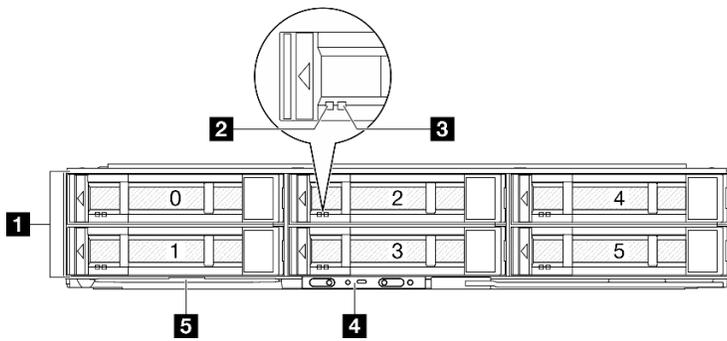
Figura 2. Configurazione con 6 unità SSD SAS/SATA/NVMe da 2,5"
