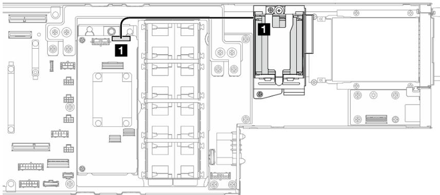
Figura 139. Instradamento dei cavi del modulo di alimentazione flash
