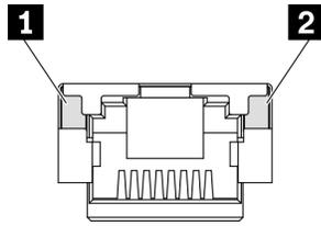
Figura 156. LED Porta di gestione del sistema XCC
