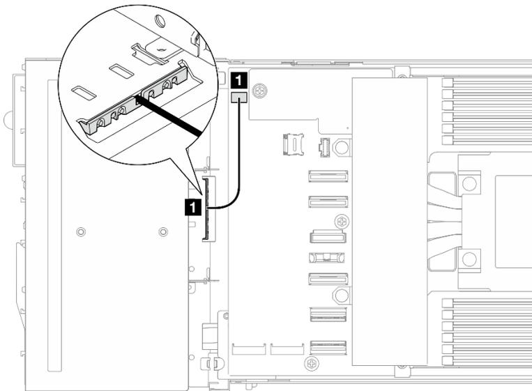
Figura 148. Instradamento dei cavi per il sensore termico anteriore
