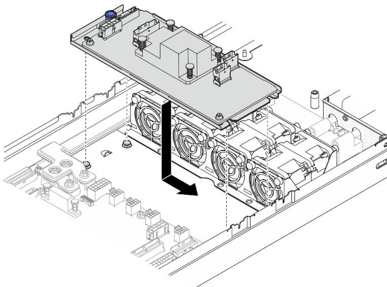
Figura 39. Installazione dell'adattatore RAID CFF interno
