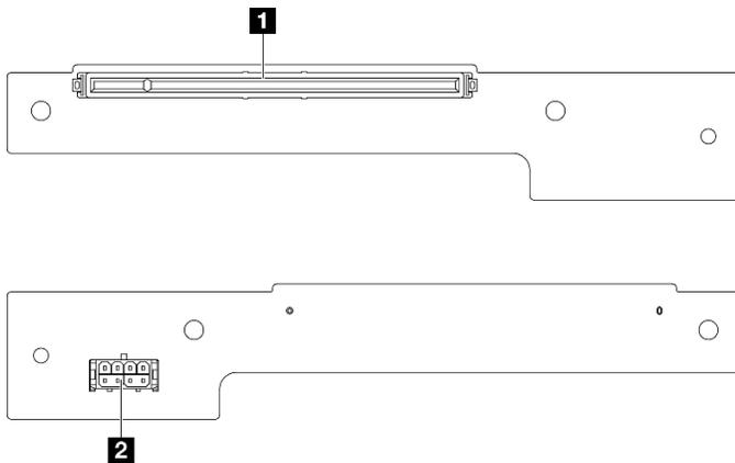
Figura 132. Connettori sulla scheda verticale PCIe
