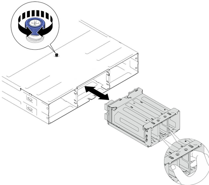
Figura 29. Installazione del telaio PSU
