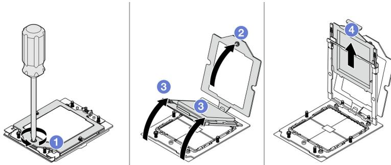
Figura 107. Rimozione di un processore
