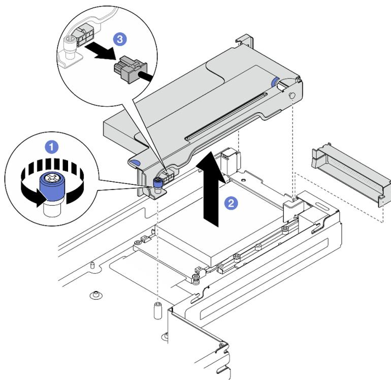
Figura 92. Rimozione dell'assieme verticale PCIe
