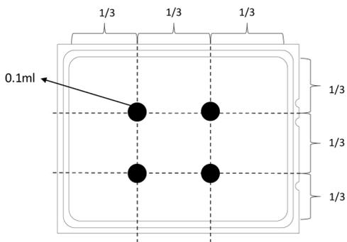
Figura 110. Applicazione del lubrificante termico
