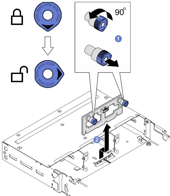
Figura 54. Rimozione del backplane I/O anteriore
