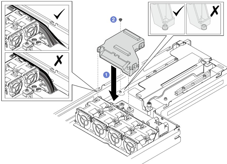
Figura 57. Installazione del condotto dell'aria GPU
