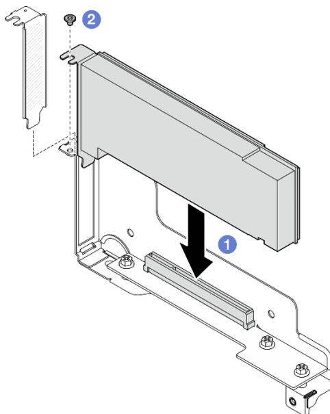
Figura 96. Installazione di un adattatore PCIe
