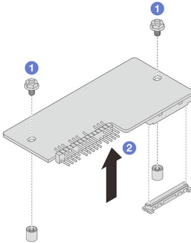
Figura 117. Rimozione del Modulo firmware e sicurezza RoT
