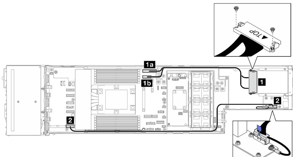
Figura 146. Cavi per i moduli I/O posteriore e OCP
