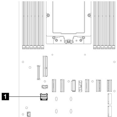
Figura 86. Posizione del socket MicroSD
