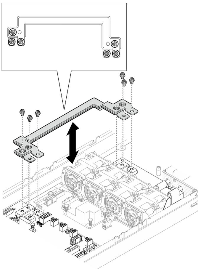
*Figura 99. Rimozione delle viti esterne della barra del bus di alimentazione*
