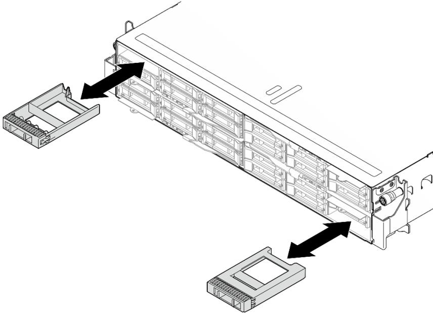
Figura 60. Sostituzione di un elemento di riempimento dell'unità
