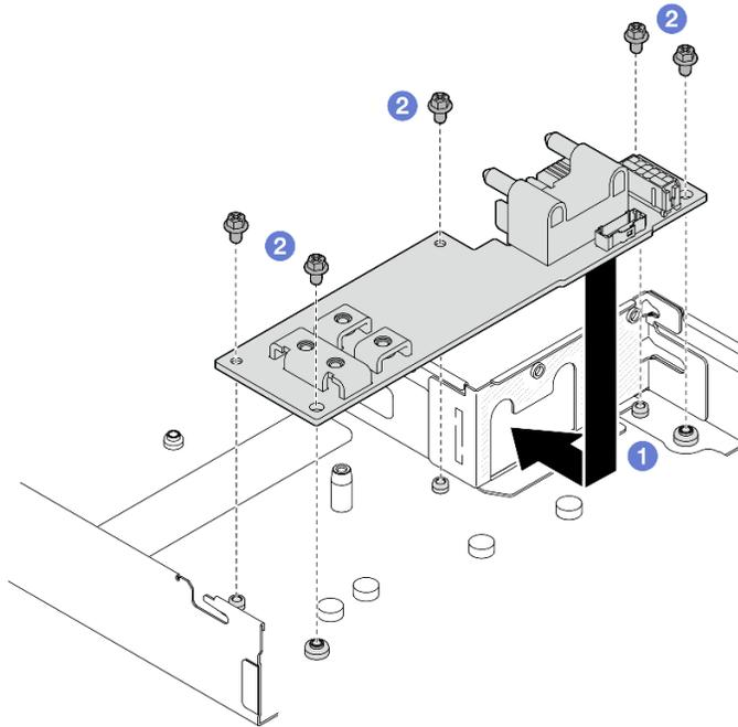
Figura 104. Installazione di una scheda di distribuzione dell'alimentazione
