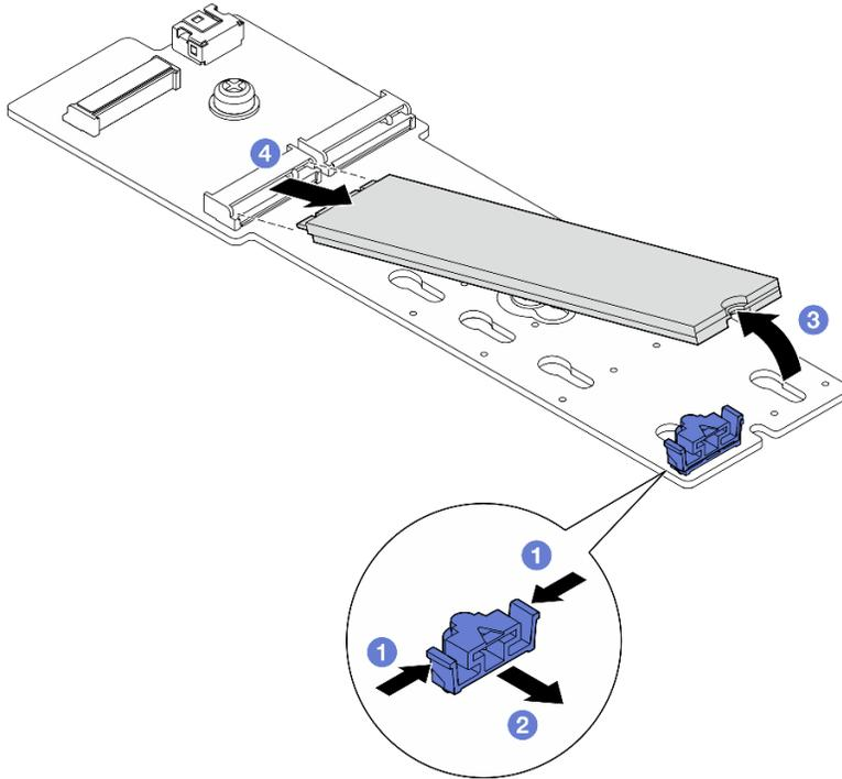
Figura 65. Rimozione di un'unità M.2
