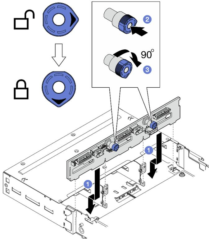
Figura 45. Installazione del backplane dell'unità
