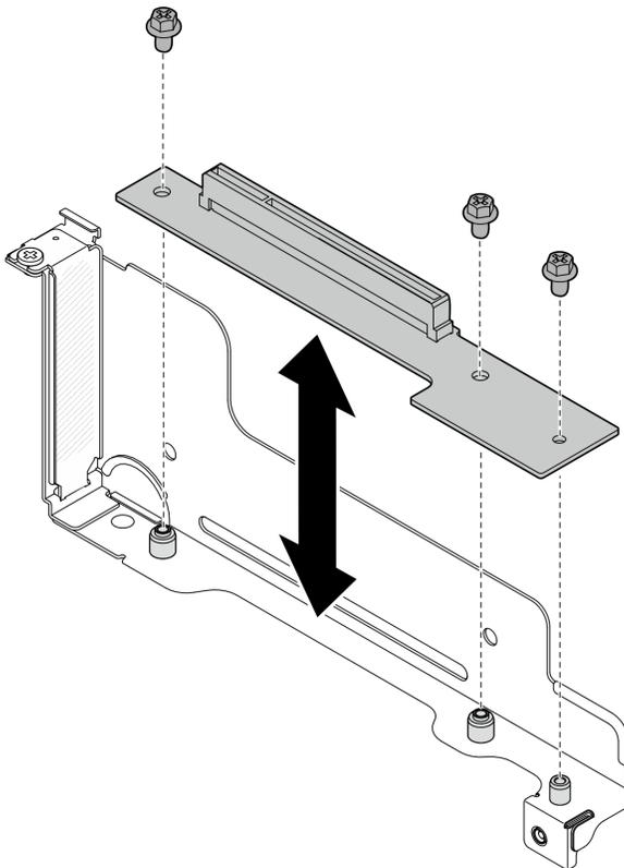
Figura 95. Sostituzione della scheda verticale PCIe
