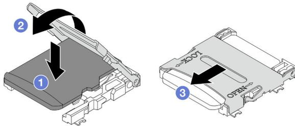
Figura 89. Installazione di una scheda MicroSD
