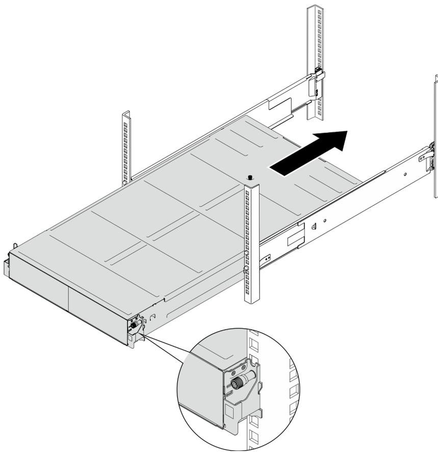
Figura 18. Installazione dello chassis
