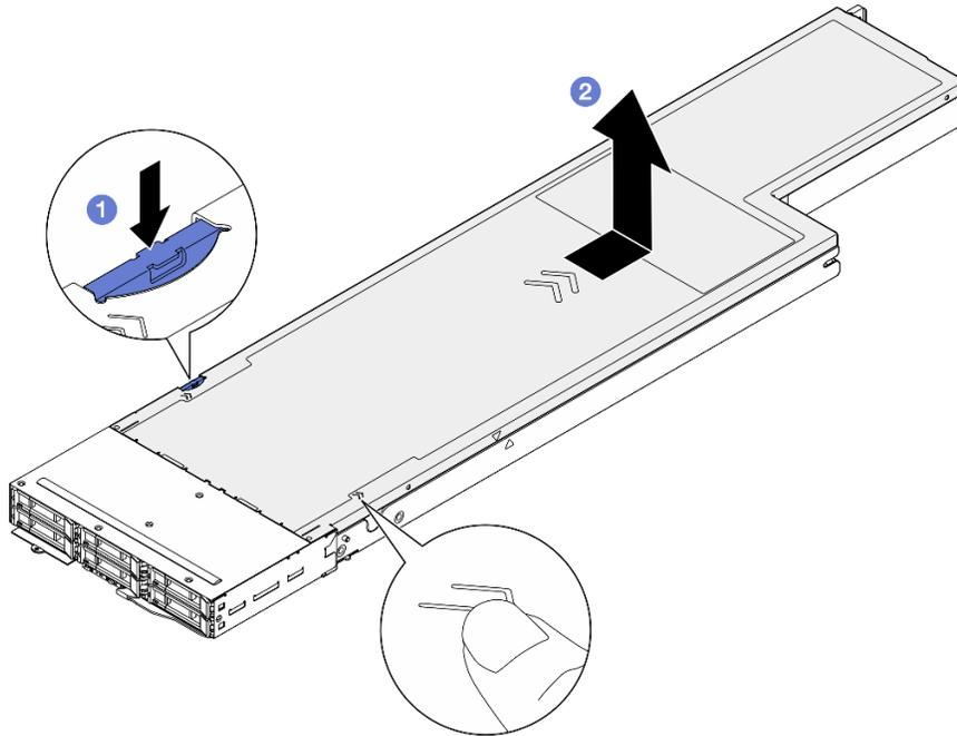
Figura 126. Rimozione del coperchio superiore
