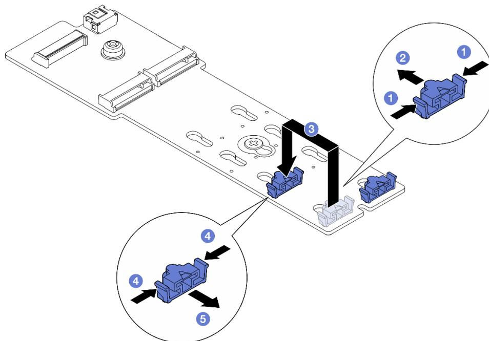
Figura 75. Regolazione del blocco M.2
