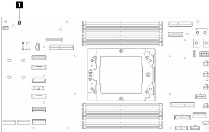
Figura 155. LED della scheda di sistema
