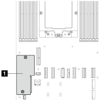
Figura 118. Posizione del Modulo firmware e sicurezza RoT
