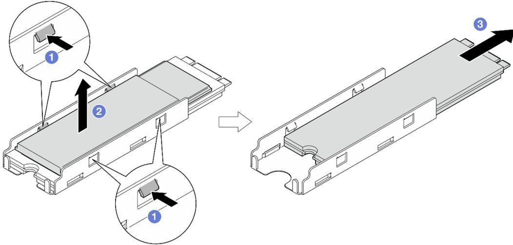
Figura 64. Rimozione del dissipatore di calore M.2
