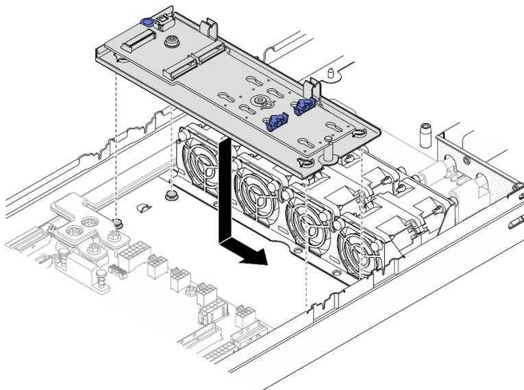
Figura 71. Installazione del vassoio dell'adattatore di avvio M.2
