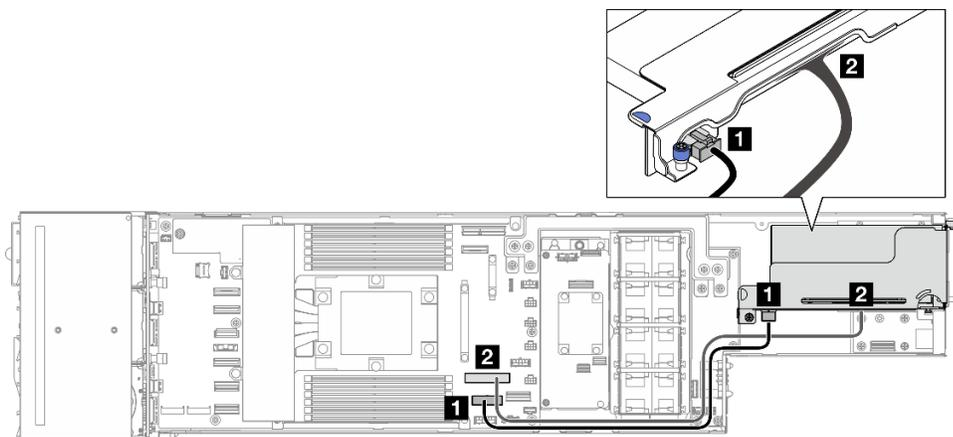
Figura 144. Instradamento dei cavi delle schede verticali PCIe
