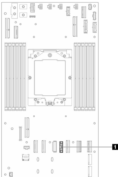
Figura 42. Posizione del socket della batteria CMOS
