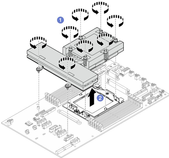
Figura 106. Rimozione di un dissipatore di calore
