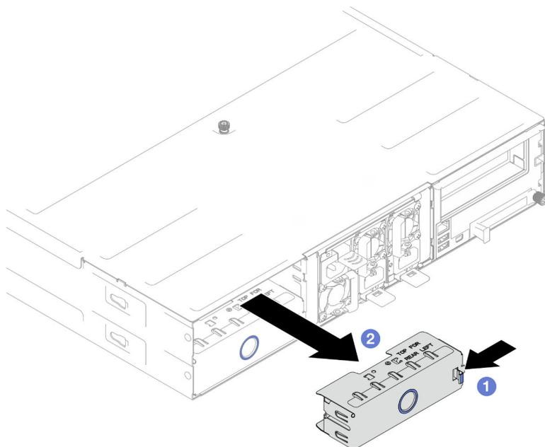
Figura 38. Rimozione di un elemento di riempimento del vassoio del nodo posteriore
