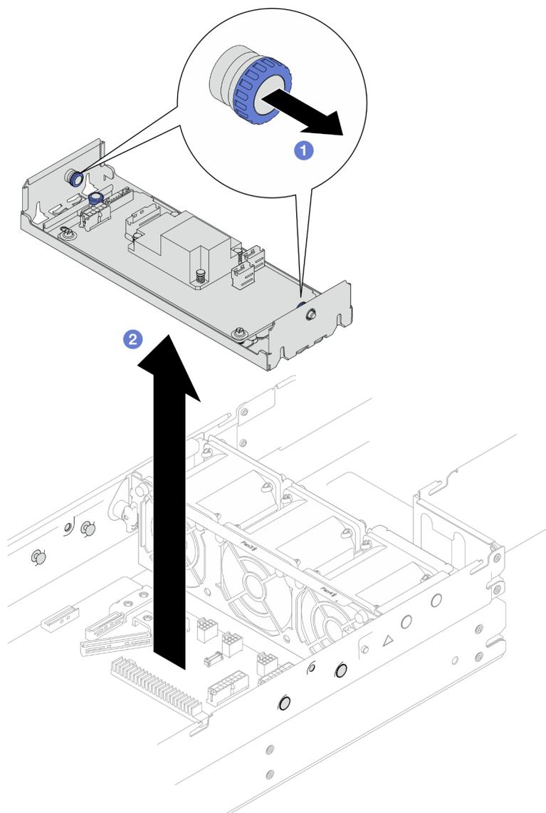
Figura 76. Rimozione della staffa dell'adattatore interno
