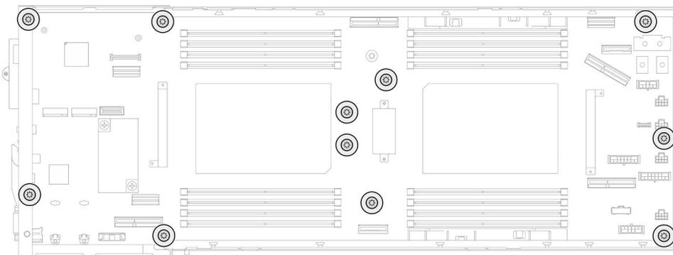
Figura 129. Rimozione delle viti
