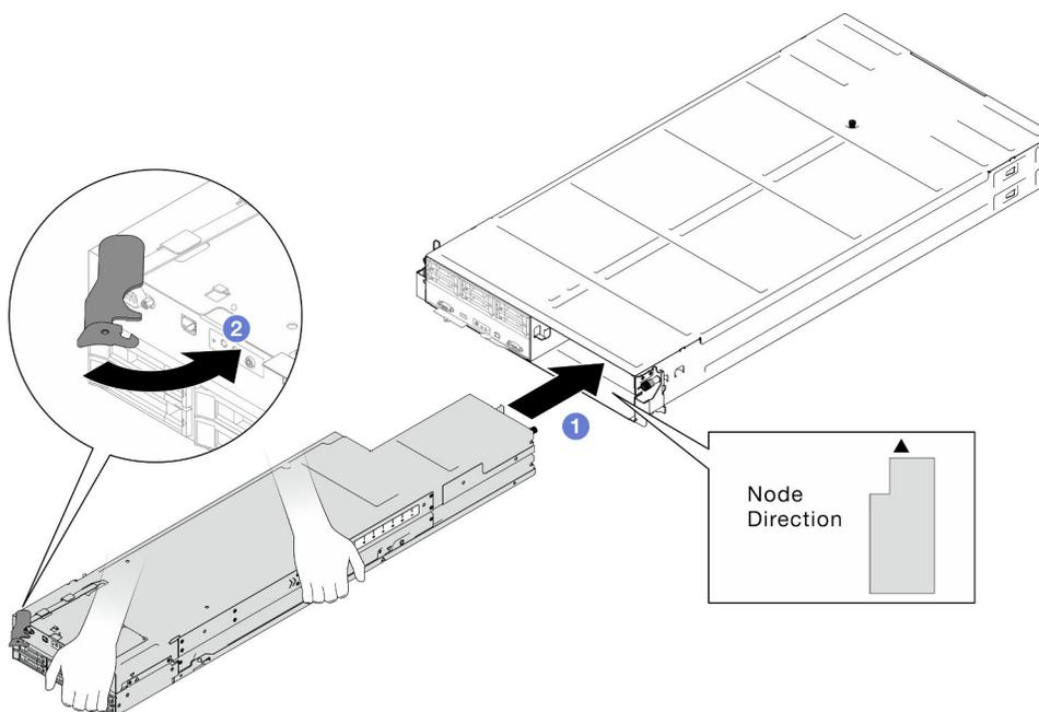
Figura 40. Installazione del nodo nel vassoio destro
