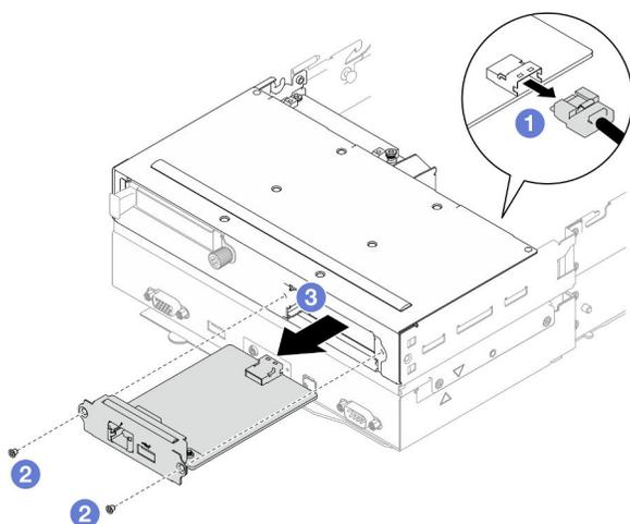
Figura 137. Rimozione del modulo di gestione XCC
