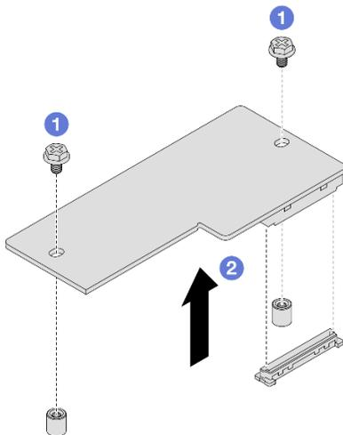
Figura 124. Rimozione del Modulo firmware e sicurezza RoT
