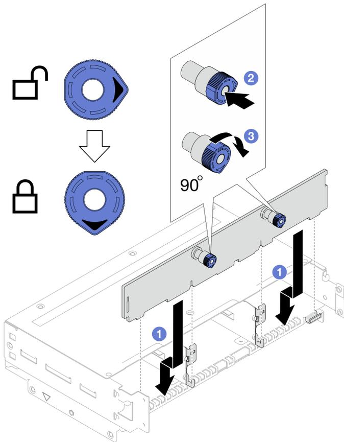
Figura 54. Installazione del backplane dell'unità
