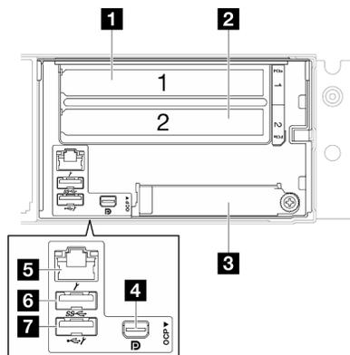
Figura 4. Vista posteriore del nodo ThinkSystem SD550 V3
