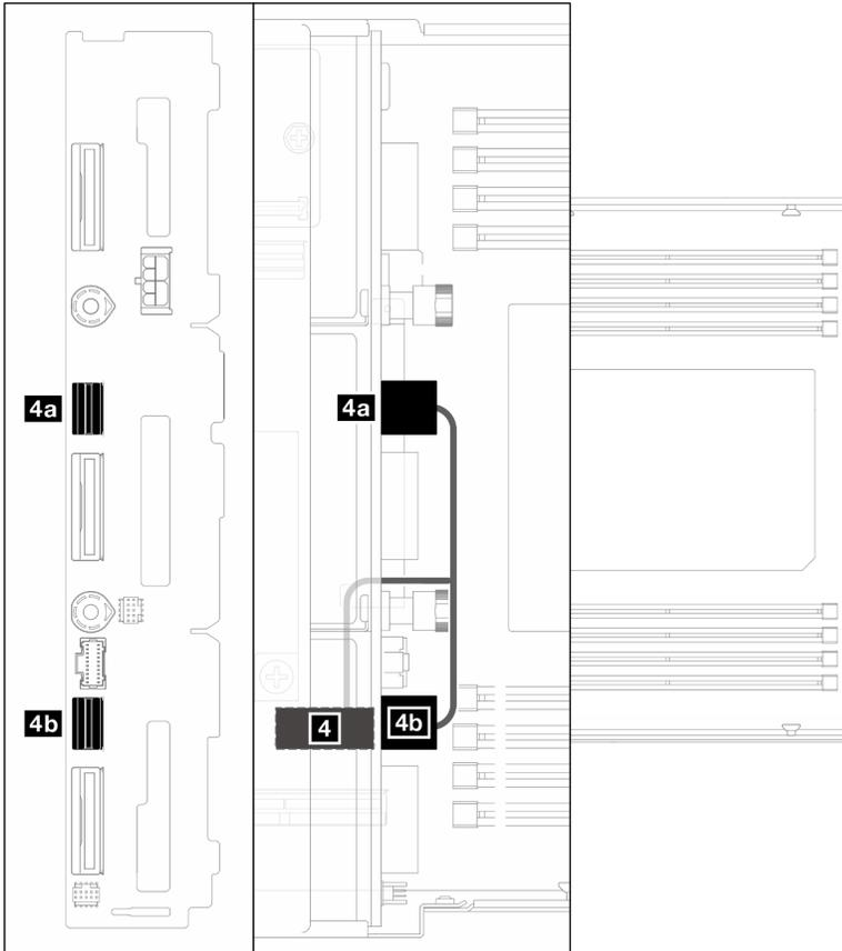
Figura 146. Instradamento dei cavi SATA - Configurazione senza RAID CFF
