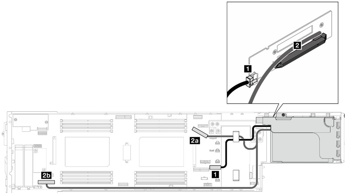
Figura 155. Intradamento dei cavi delle schede verticali PCIe – un processore
