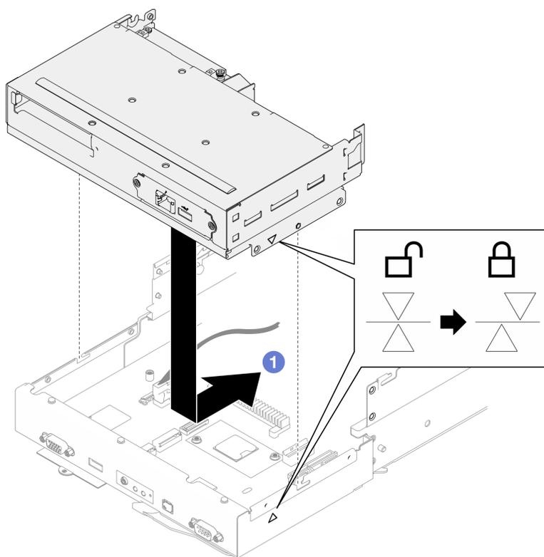
Figura 66. Installazione del telaio OCP anteriore
