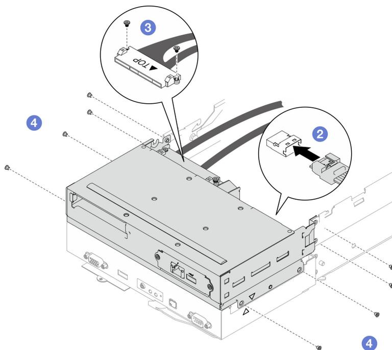
Passo 4. Fissare il cavo di messa a terra al telaio OCP anteriore con una vite come illustrato.
