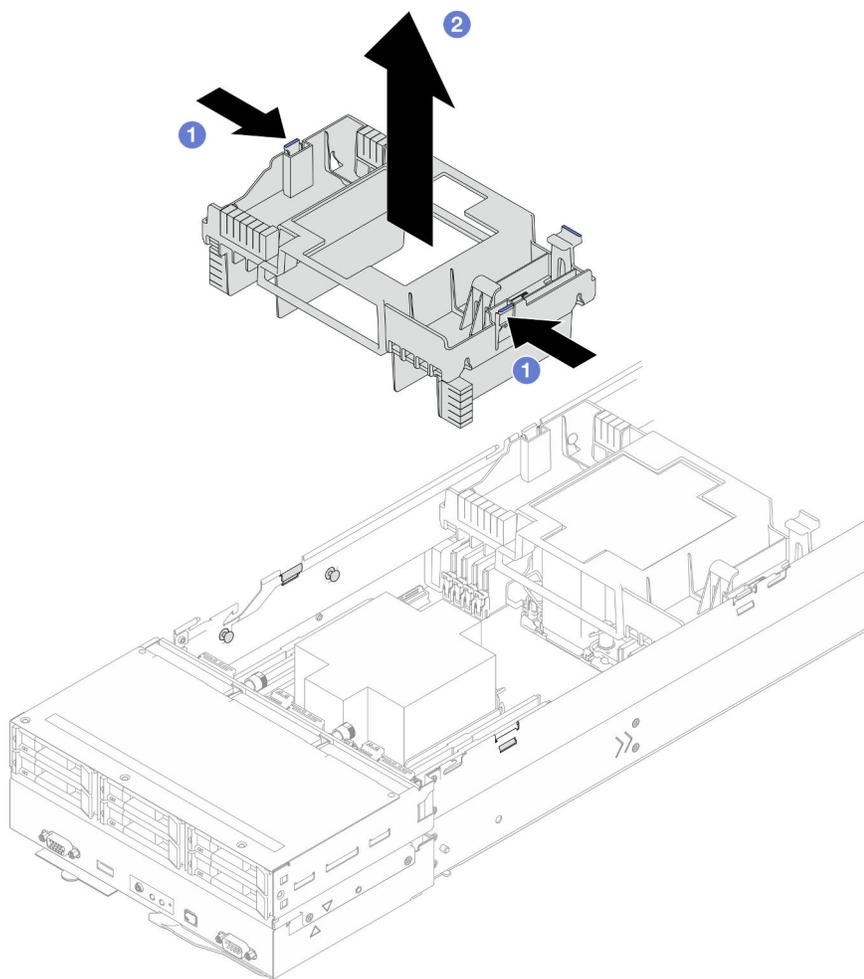
*Figura 41. Rimozione del deflettore d'aria anteriore*
