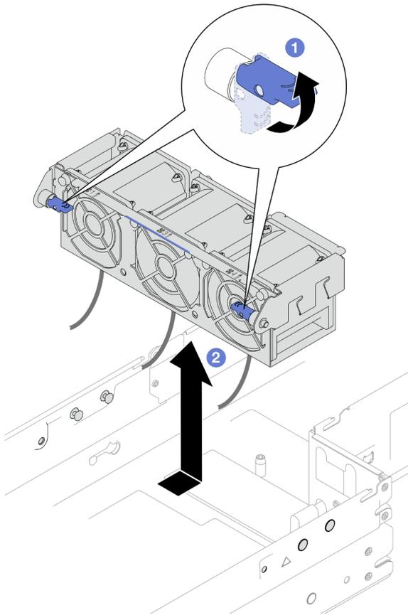
Figura 56. Rimozione dell'alloggiamento della ventola
