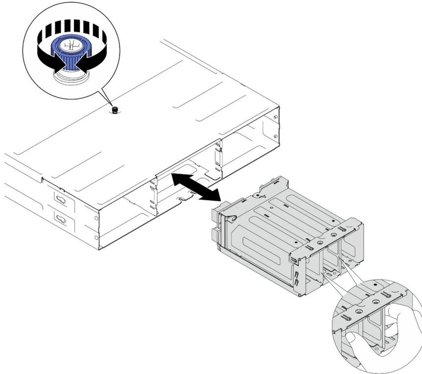
Figura 32. Installazione del telaio PSU
