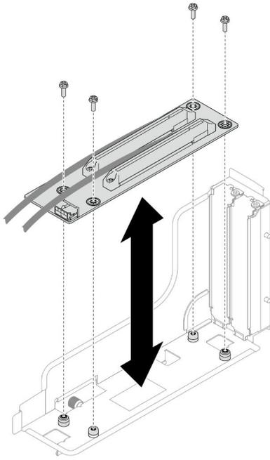
Figura 96. Sostituzione della scheda verticale PCIe
