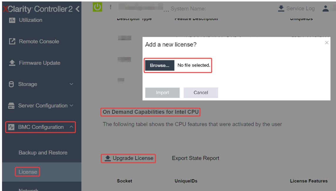
Figura 162. Caricamento della chiave di attivazione tramite la GUI Web di XCC
