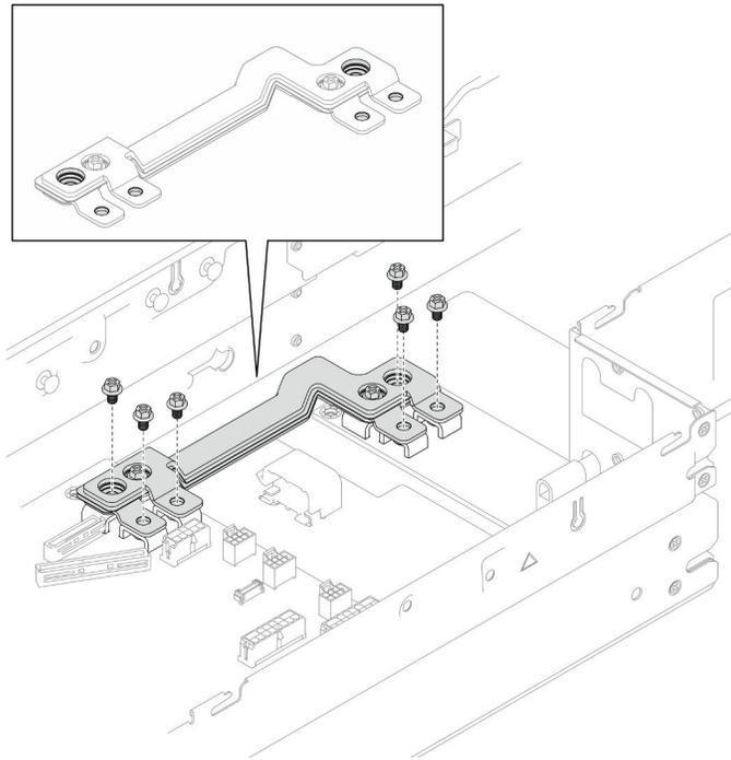
Figura 103. Installazione delle viti della barra del bus di alimentazione
