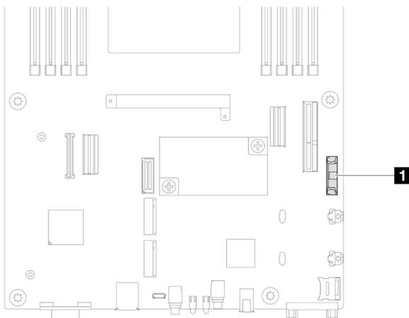
Figura 50. Posizione del socket della batteria CMOS
