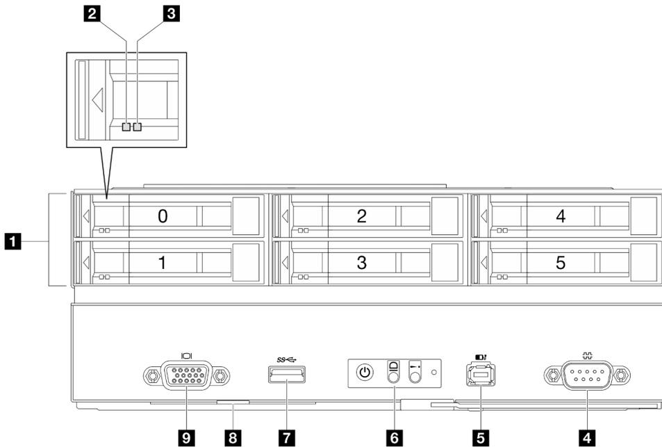
Figura 2. Configurazione con massimo sei unità da 2,5"
