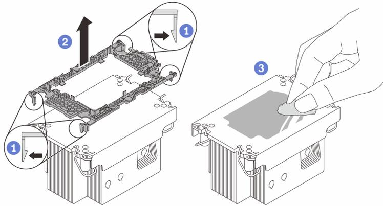
Figura 110. Separazione di una piastra del processore dal dissipatore di calore
