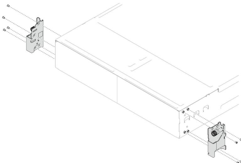
Figura 23. Installazione delle staffe EIA
