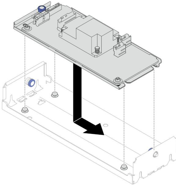
Figura 47. Installazione dell'adattatore RAID CFF interno sulla staffa
