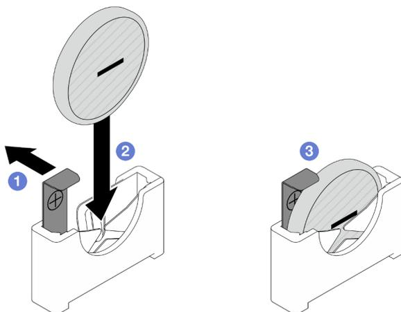
Figura 51. Installazione di una batteria CMOS
