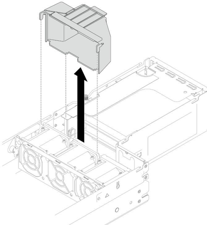
Figura 68. Rimozione del condotto dell'aria GPU
