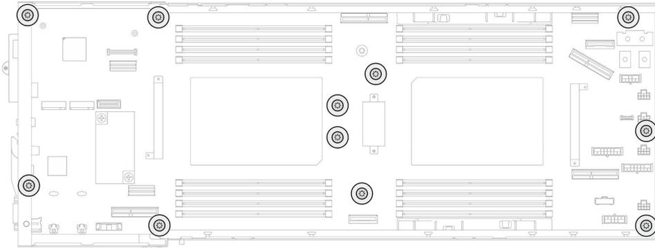
Figura 133. Installazione delle viti sulla scheda di sistema
