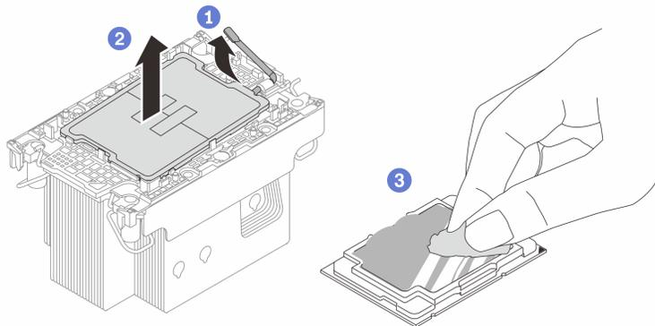
*Figura 109. Separazione di una piastra del processore dal dissipatore di calore*
