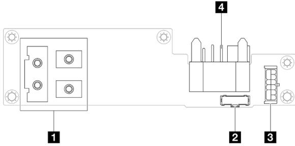
Figura 143. Connettori della scheda di distribuzione dell'alimentazione
