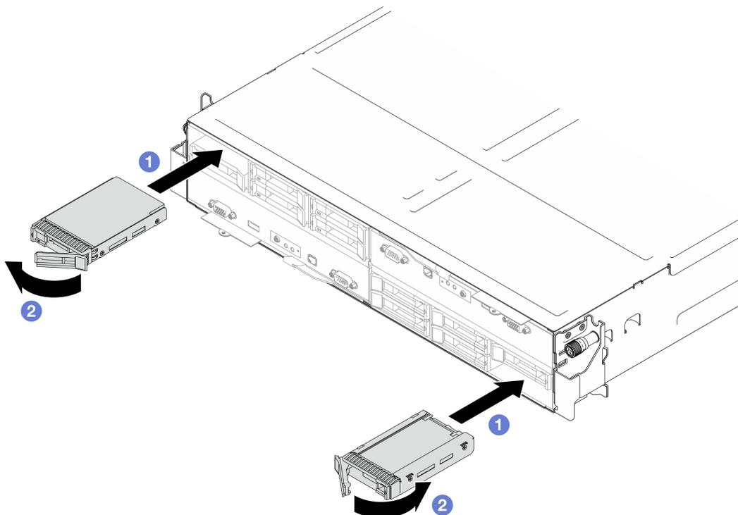
Figura 75. Installazione di un'unità SSD da 15 mm
