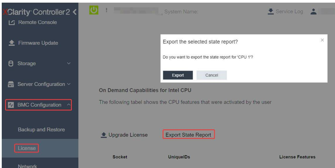
Figura 163. Esportare il report sullo stato tramite la GUI Web di XCC
