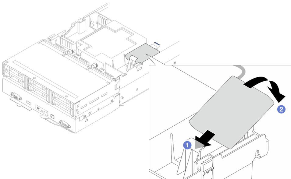
Figura 61. Installazione del modulo di alimentazione flash
