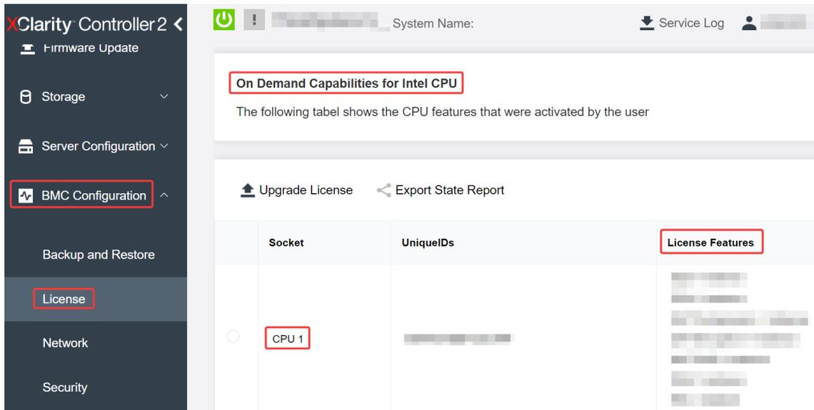
Figura 164. Verifica delle funzioni Intel On Demand installate in un processore nella GUI Web di XCC
