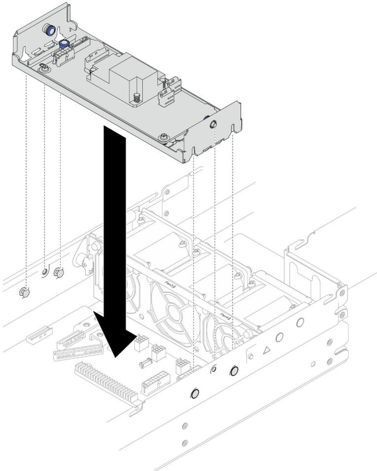
*Figura 77. Installazione della staffa dell'adattatore interno*
