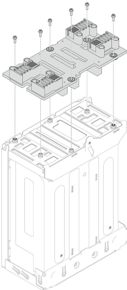
Figura 30. Rimozione del midplane dello chassis
