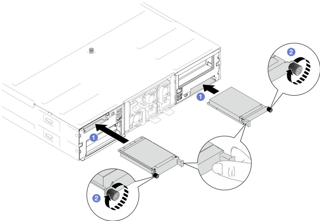
Figura 92. Installazione del modulo OCP posteriore
