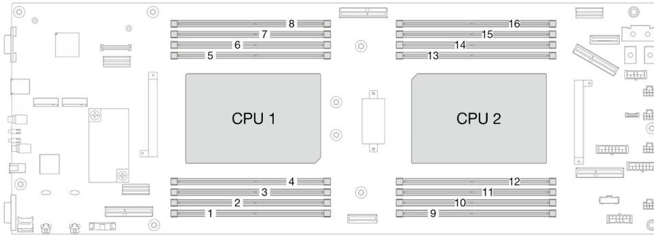
Figura 83. Modulo di memoria e posizione del processore
