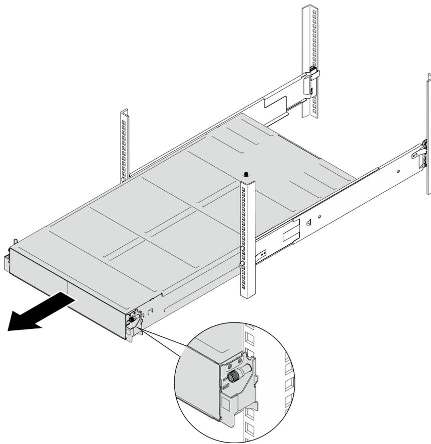
Figura 18. Rimozione dello chassis
