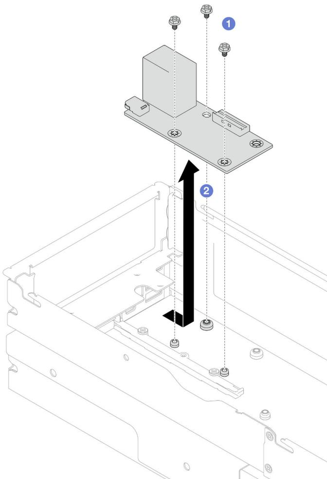
Figura 118. Rimozione del modulo I/O posteriore
