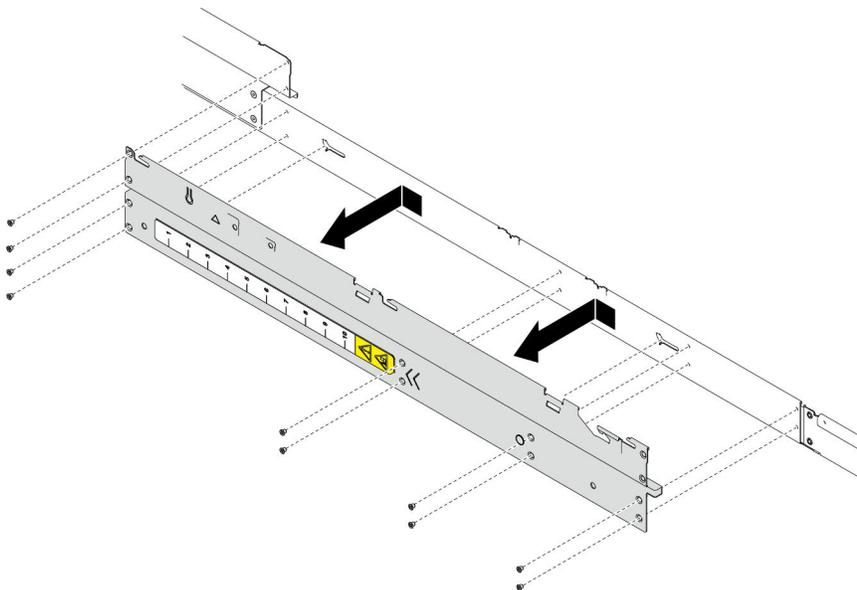
Figura 121. Rimozione della staffa laterale
