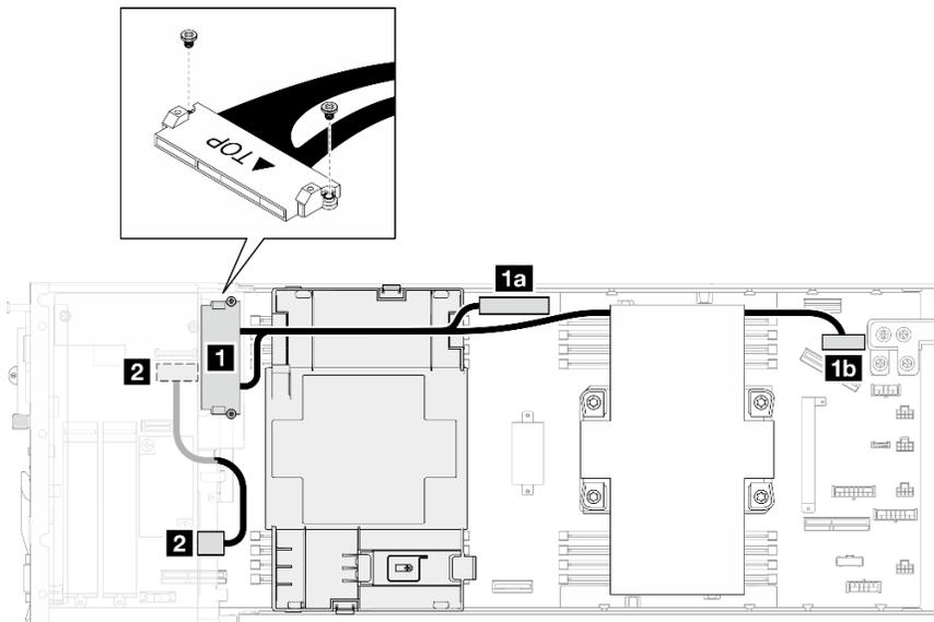
Figura 153. Cavo OCP e cavo I/O anteriore nella configurazione OCP anteriore
