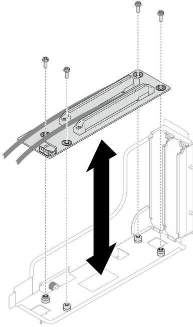
Figura 98. Sostituzione della scheda verticale PCIe
