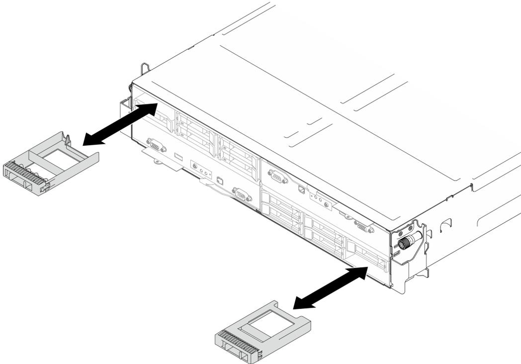
Figura 72. Sostituzione di un elemento di riempimento dell'unità
