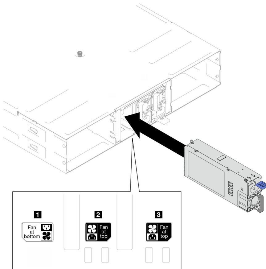
Figura 27. Installazione di un alimentatore hot-swap
