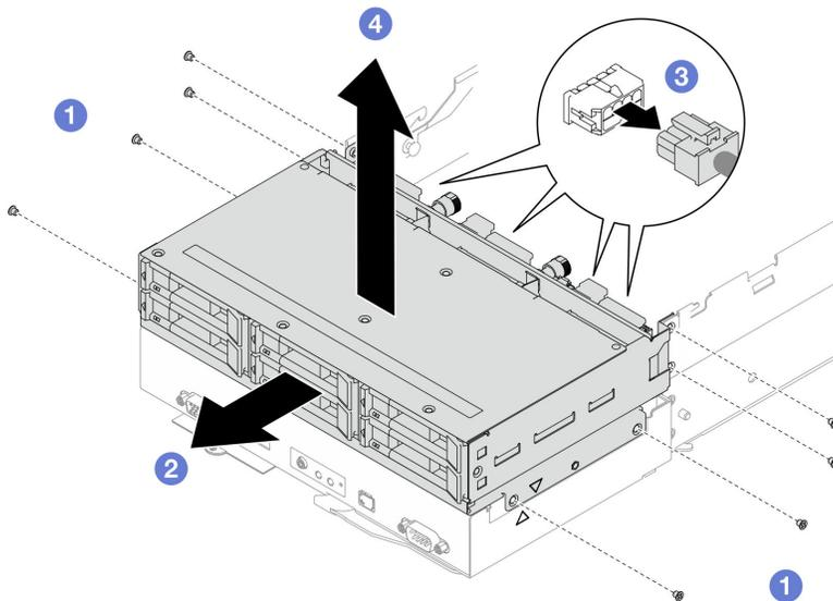
Figura 52. Rimozione dell'assieme del telaio unità
