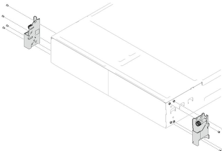
Figura 22. Rimozione delle staffe EIA
