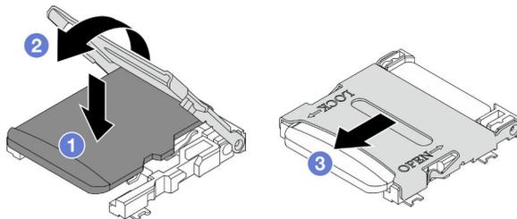
Figura 90. Installazione di una scheda MicroSD
