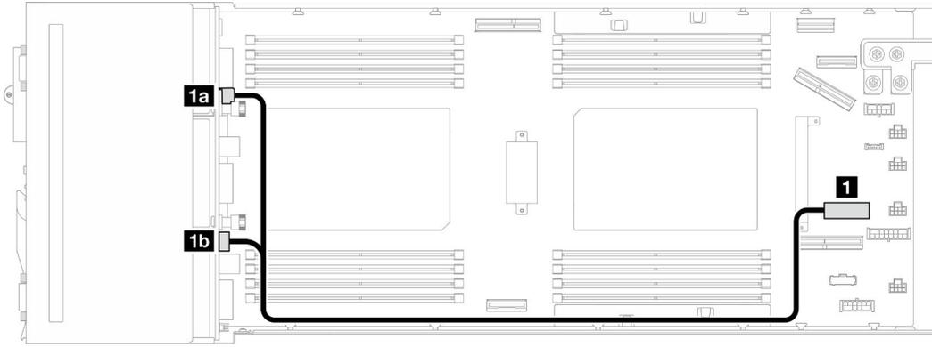
Figura 147. Instradamento dei cavi di alimentazione del backplane dell'unità
