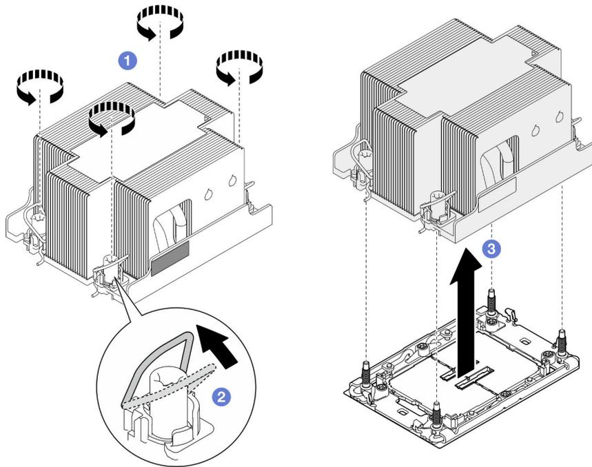
Figura 107. Rimozione del PHM 2U standard
