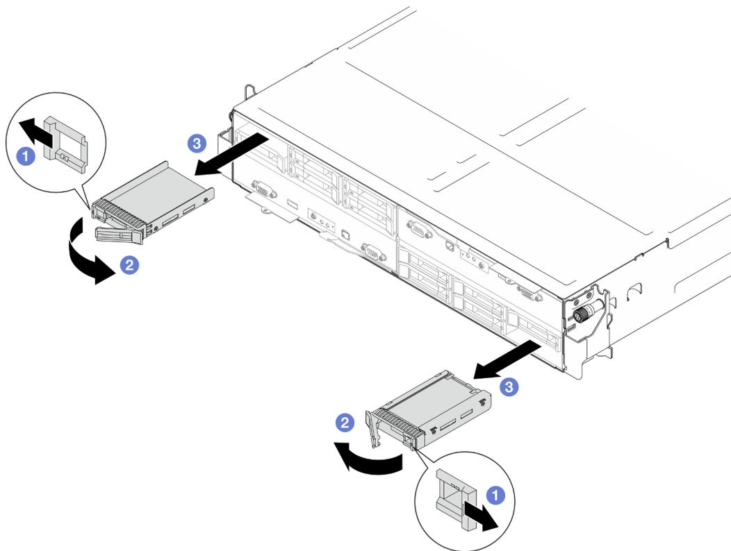
Figura 70. Rimozione di un'unità SSD da 7 mm
