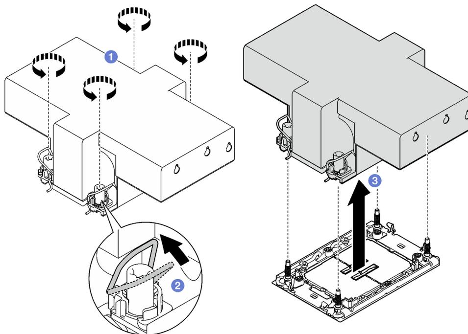
Figura 108. Rimozione del PHM 2U ad alte prestazioni
