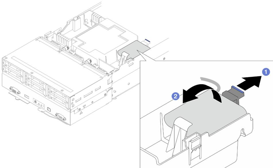
Figura 60. Rimozione del modulo di alimentazione flash
