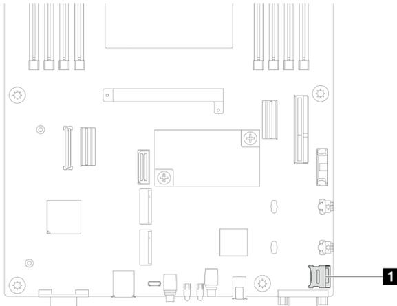
Figura 89. Posizione del socket MicroSD
