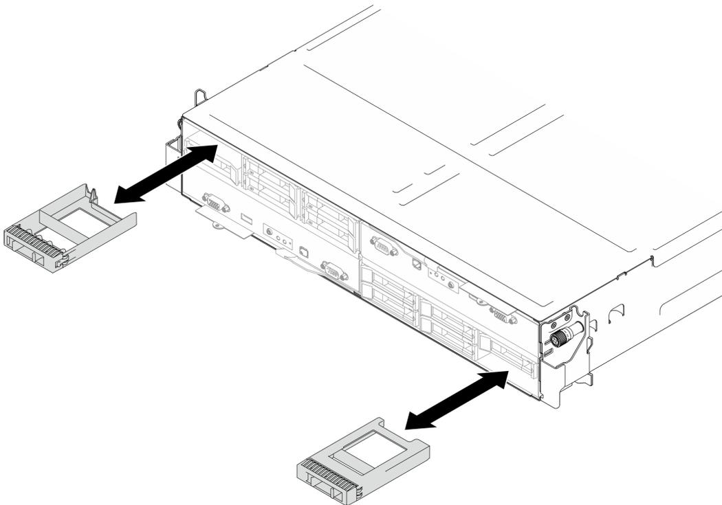
Figura 73. Sostituzione di un elemento di riempimento dell'unità
