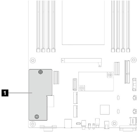
Figura 123. Posizione del Modulo firmware e sicurezza RoT
