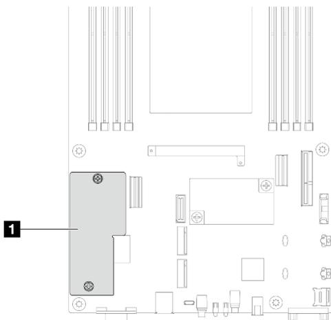
Figura 125. Posizione del Modulo firmware e sicurezza RoT
