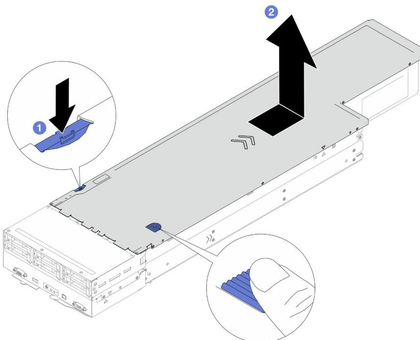
Figura 135. Rimozione del coperchio superiore
