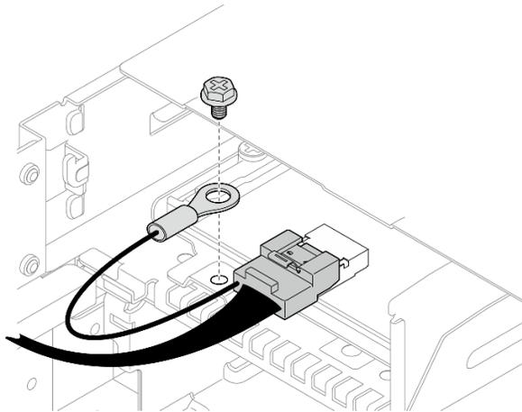
Figura 154. Vite del cavo di messa a terra I/O anteriore
