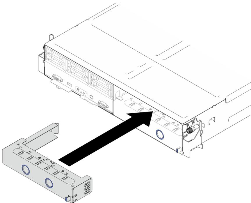
Figura 35. Installazione di un elemento di riempimento del vassoio del nodo anteriore
