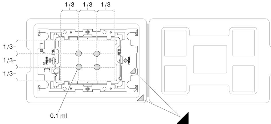
Figura 113. Applicazione del lubrificante termico con il processore nella confezione di spedizione
