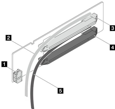
Figura 142. Connettori e cavi della scheda verticale PCIe a due slot
