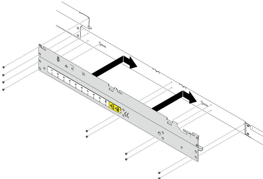
Figura 122. Installazione della staffa laterale
