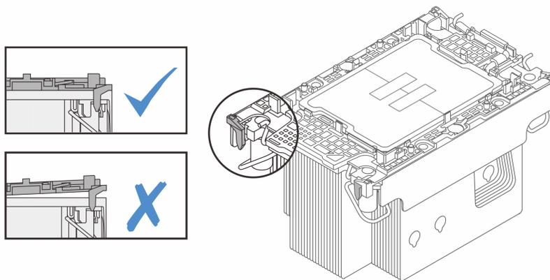
Figura 114. Assemblaggio del PHM con il processore nella confezione di spedizione
