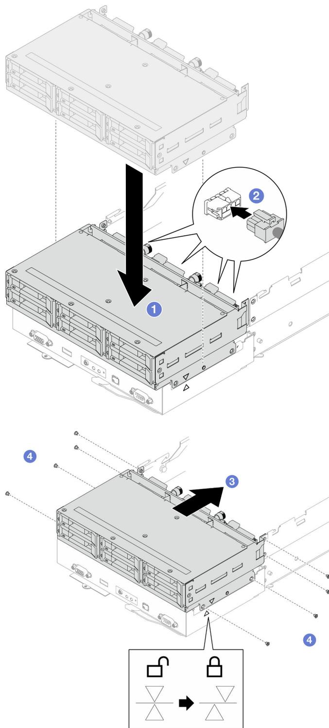
Figura 55. Installazione dell'assieme del telaio unità
