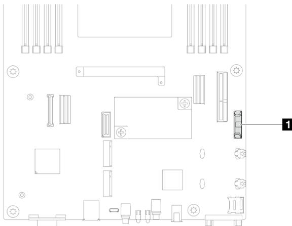
Figura 48. Posizione del socket della batteria CMOS
