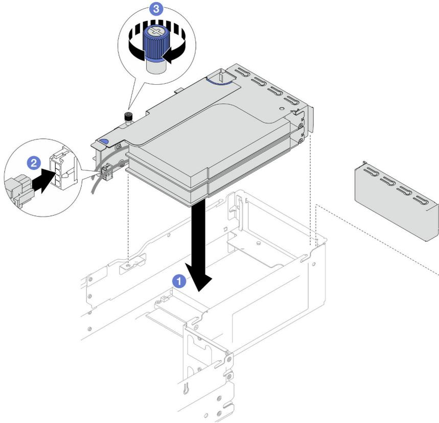
Figura 99. Installazione dell'assieme verticale PCIe
