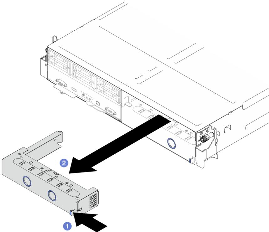
Figura 37. Rimozione di un elemento di riempimento del vassoio del nodo anteriore
