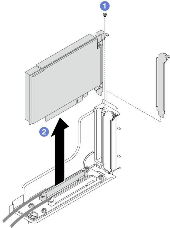
Figura 95. Rimozione di un adattatore PCIe
