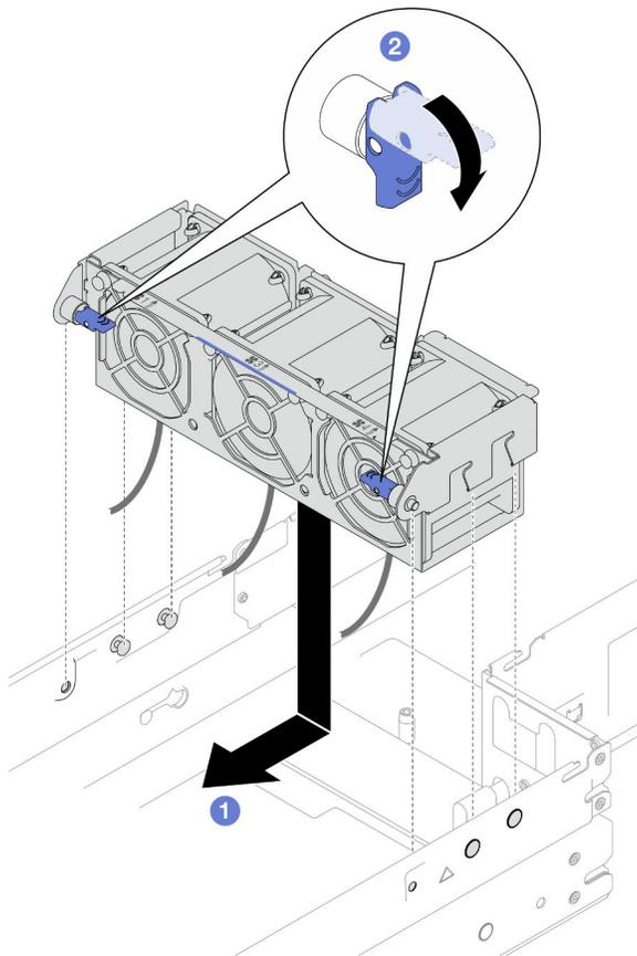
Figura 59. Installazione dell'alloggiamento della ventola
