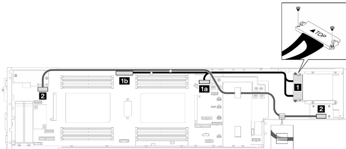
Figura 158. Cavi per i moduli I/O posteriore e OCP
