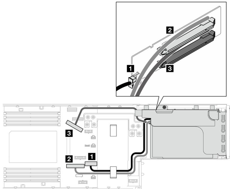
Figura 156. Instradamento dei cavi delle schede verticali PCIe – due processori
