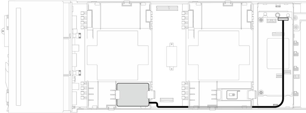
Figura 152. Cavo del modulo di alimentazione flash e RAID CFF
