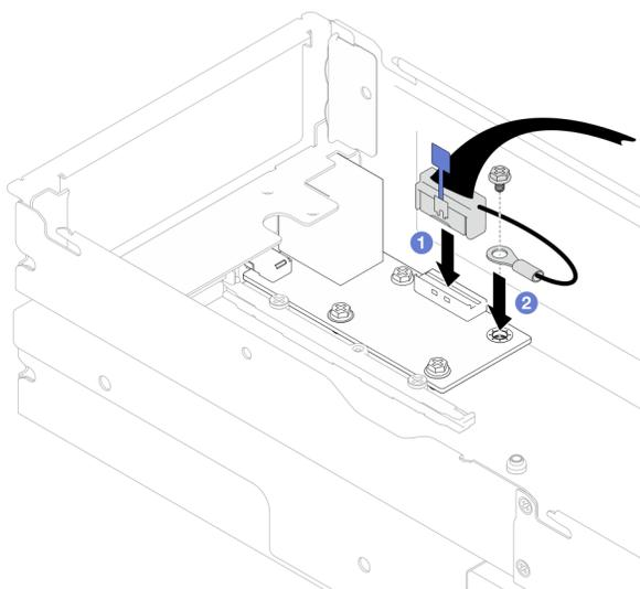
Figura 159. Installazione del cavo I/O posteriore e del cavo di messa a terra
