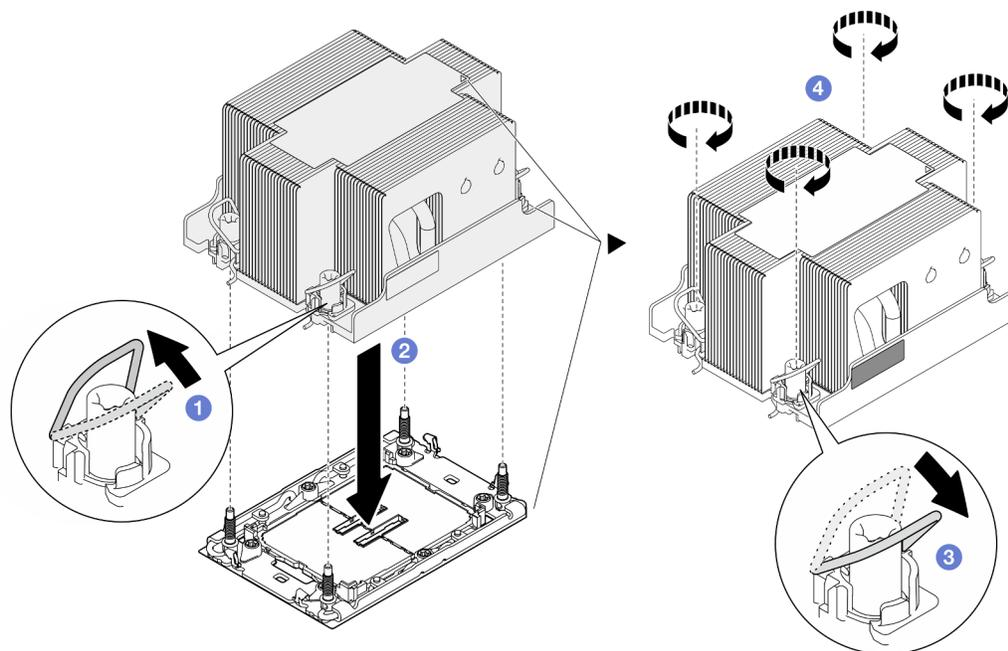
Figura 115. Installazione di un PHM 2U standard
