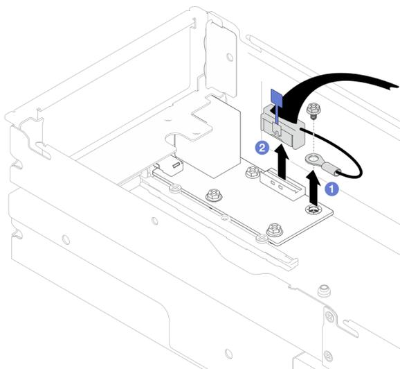
*Figura 117. Rimozione del cavo I/O posteriore e del cavo di messa a terra*
