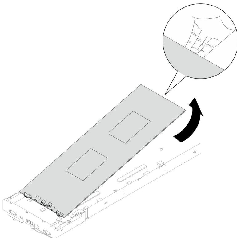
Figura 130. Rimozione della scheda di sistema
