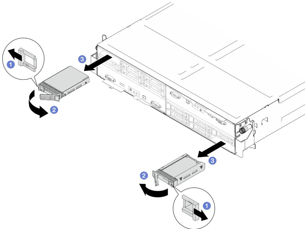
Figura 71. Rimozione di un'unità SSD da 15 mm
