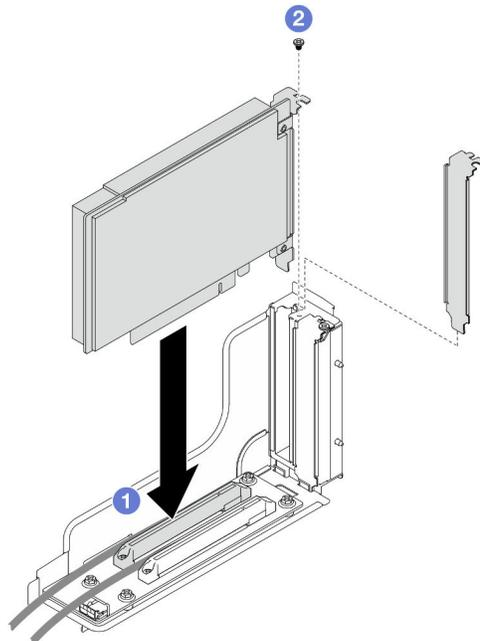
Figura 97. Installazione di un adattatore PCIe
