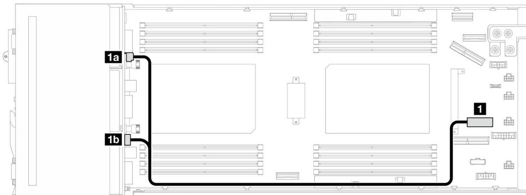
Figura 144. Instradamento dei cavi di alimentazione del backplane dell'unità
