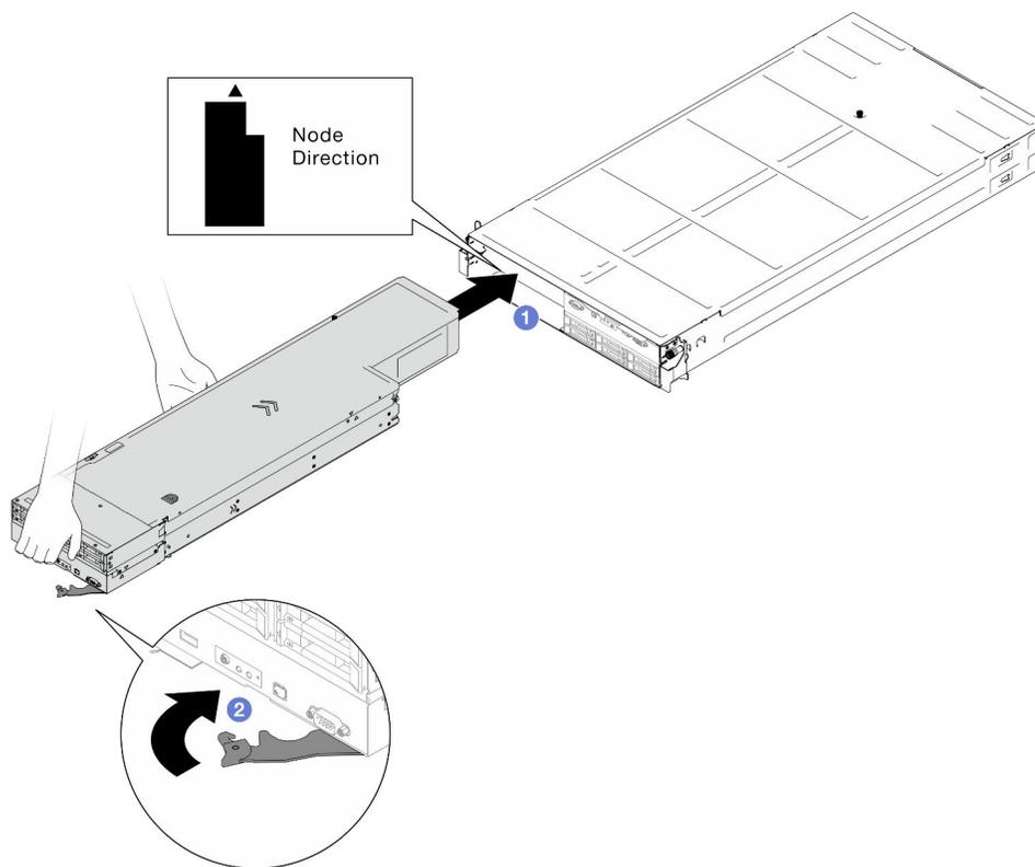
Figura 39. Installazione del nodo nel vassoio sinistro
