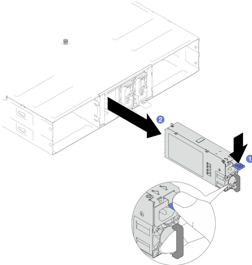
Figura 24. Rimozione di una PSU hot-swap
