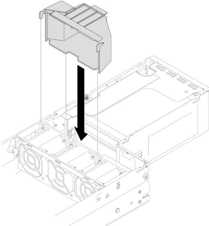
Figura 69. Installazione del condotto dell'aria GPU
