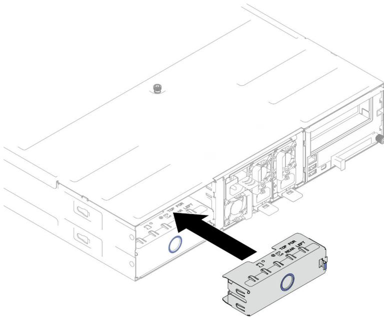
Figura 36. Installazione di un elemento di riempimento del vassoio del nodo posteriore
