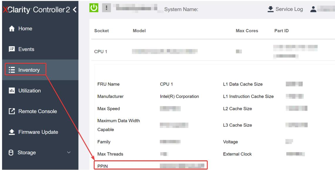
Figura 161. Lettura del PPIN tramite la GUI Web di XCC
