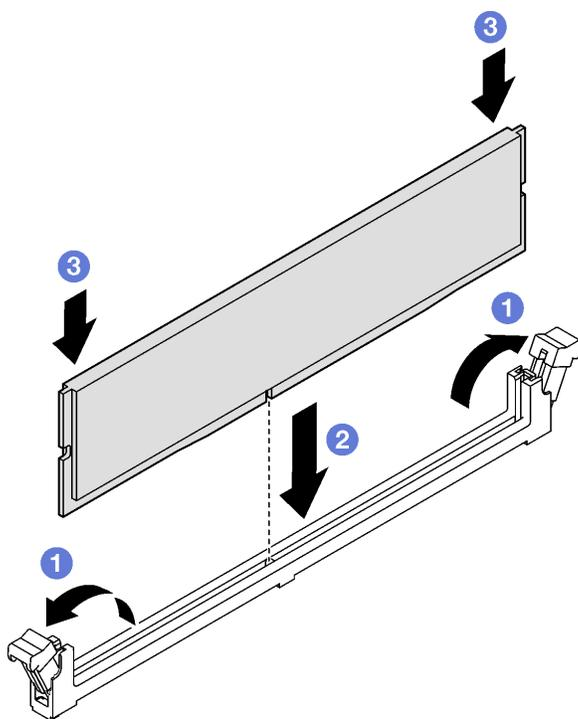
Figura 86. Installazione di un modulo di memoria
