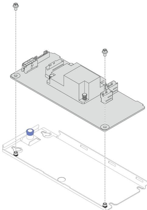
Figura 46. Separazione dell'adattatore RAID CFF interno dal vassoio
