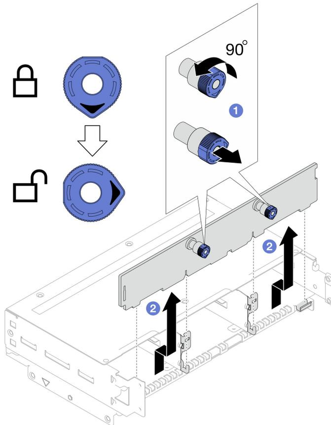
Figura 53. Rimozione del backplane dell'unità
