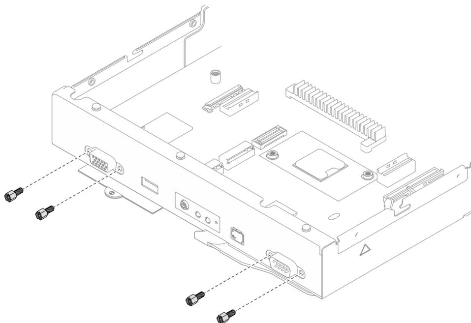
*Figura 132. Installazione delle viti della scheda di sistema sulla parte anteriore*
