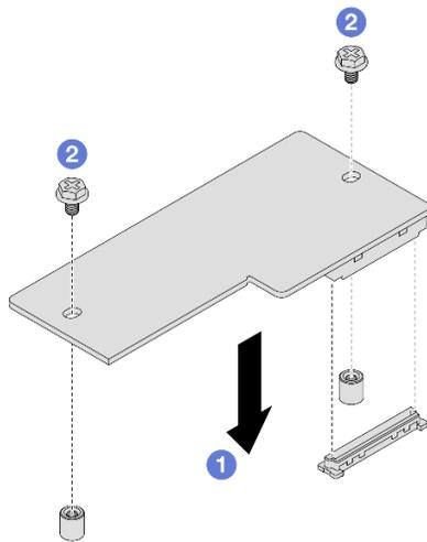
Figura 126. Installazione del modulo firmware e sicurezza RoT
