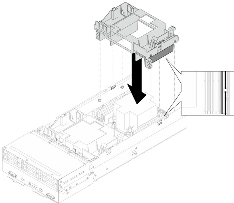
Figura 44. Installazione del deflettore d'aria posteriore
