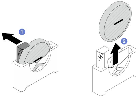
Figura 49. Rimozione della batteria CMOS
