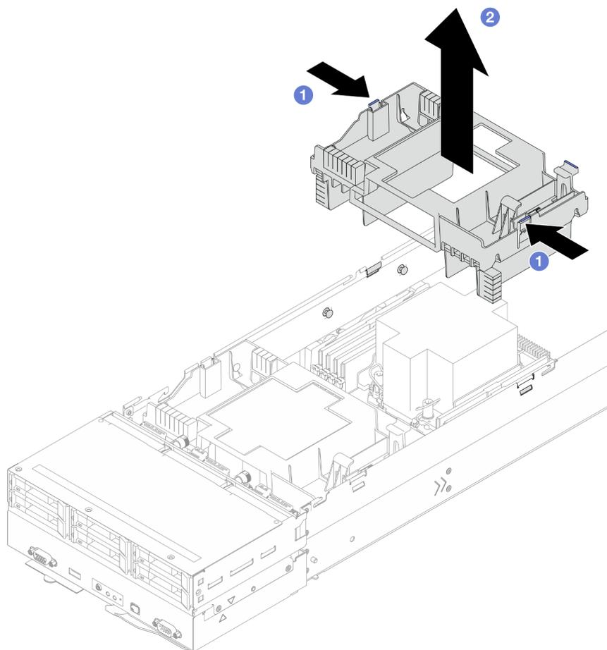
Figura 42. Rimozione del deflettore d'aria posteriore
