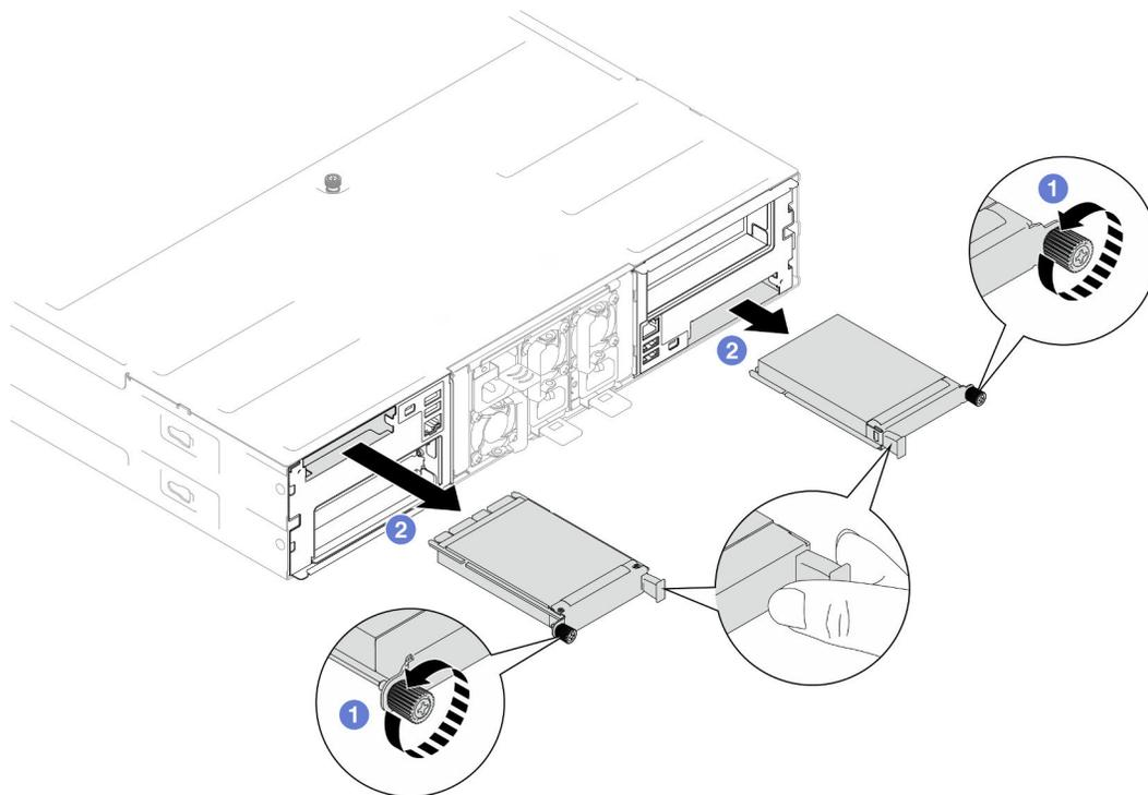
Figura 91. Rimozione del modulo OCP posteriore
