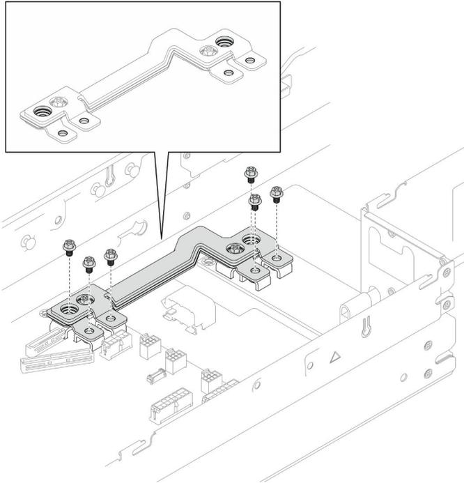
Figura 100. Rimozione delle viti esterne della barra del bus di alimentazione
