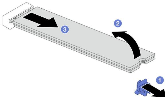
Figura 79. Rimozione di un'unità M.2
