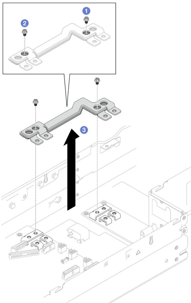
Figura 101. Rimozione della barra del bus di alimentazione
