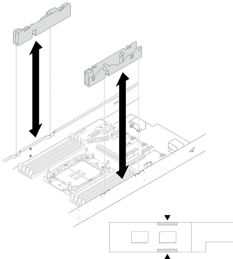
Figura 134. Sostituzione dei condotti dei cavi
