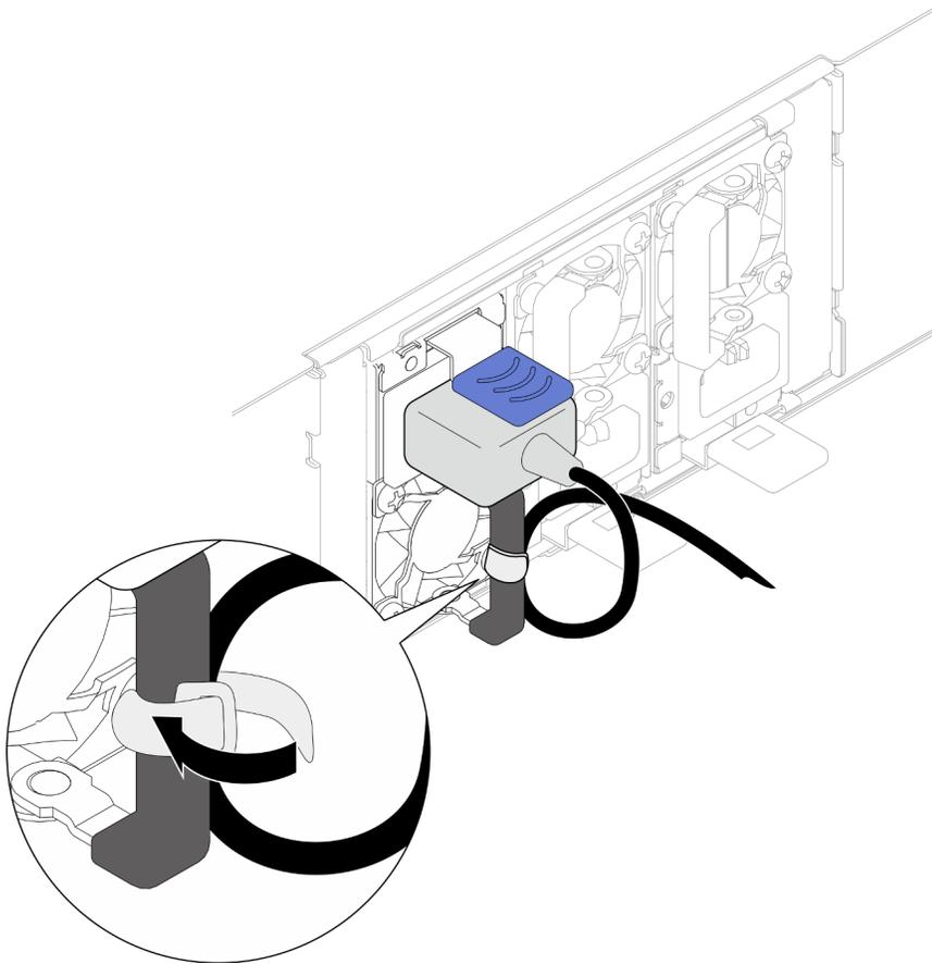
Figura 28. Instradamento e fissaggio del cavo di alimentazione
