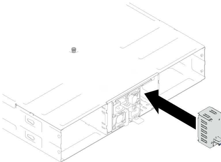
Figura 25. Installazione di un elemento di riempimento PSU
