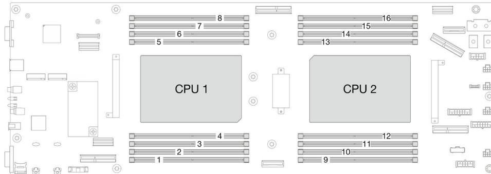
Figura 85. Modulo di memoria e posizione del processore
