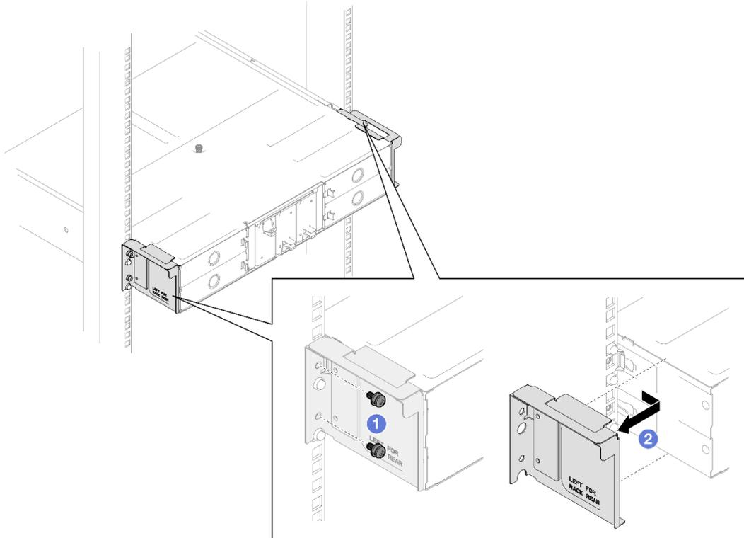
Figura 17. Rimozione delle staffe di spedizione per rack profondi 29,5 pollici
