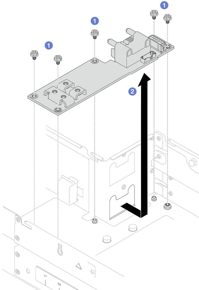
Figura 104. Rimozione della scheda di distribuzione dell'alimentazione
