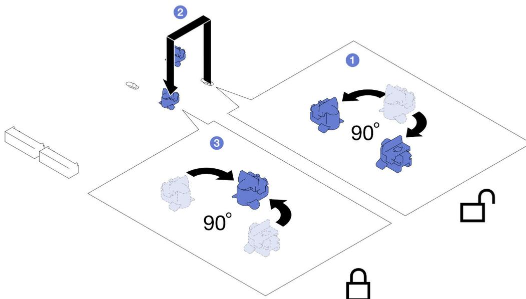
Figura 80. Regolazione del fermo di un'unità M.2
