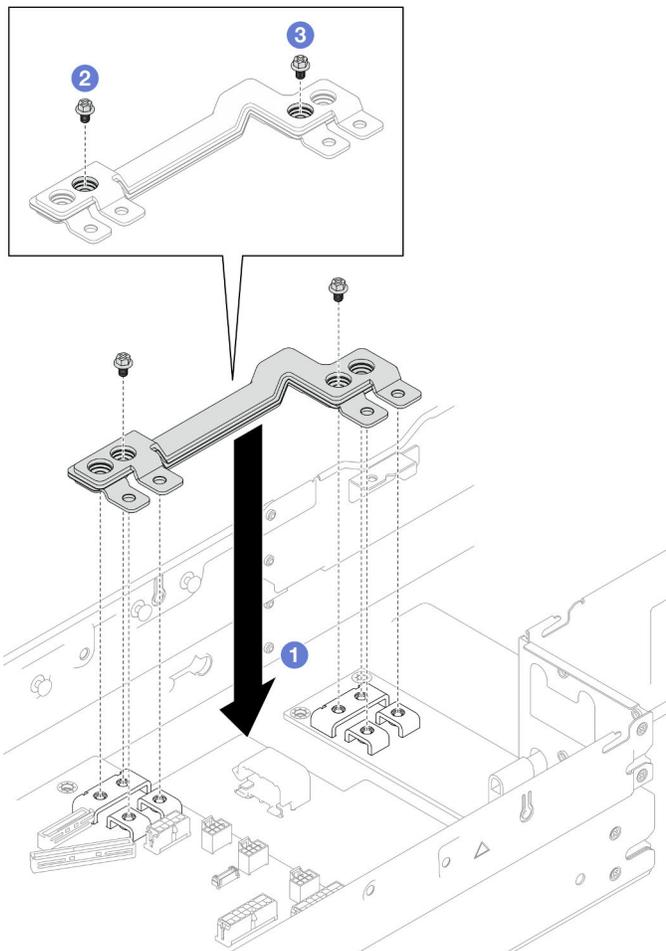
Figura 102. Installazione della barra del bus di alimentazione
