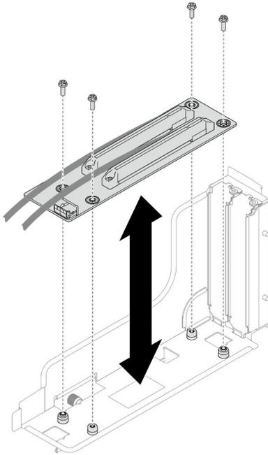
Figura 94. Sostituzione della scheda verticale PCIe
