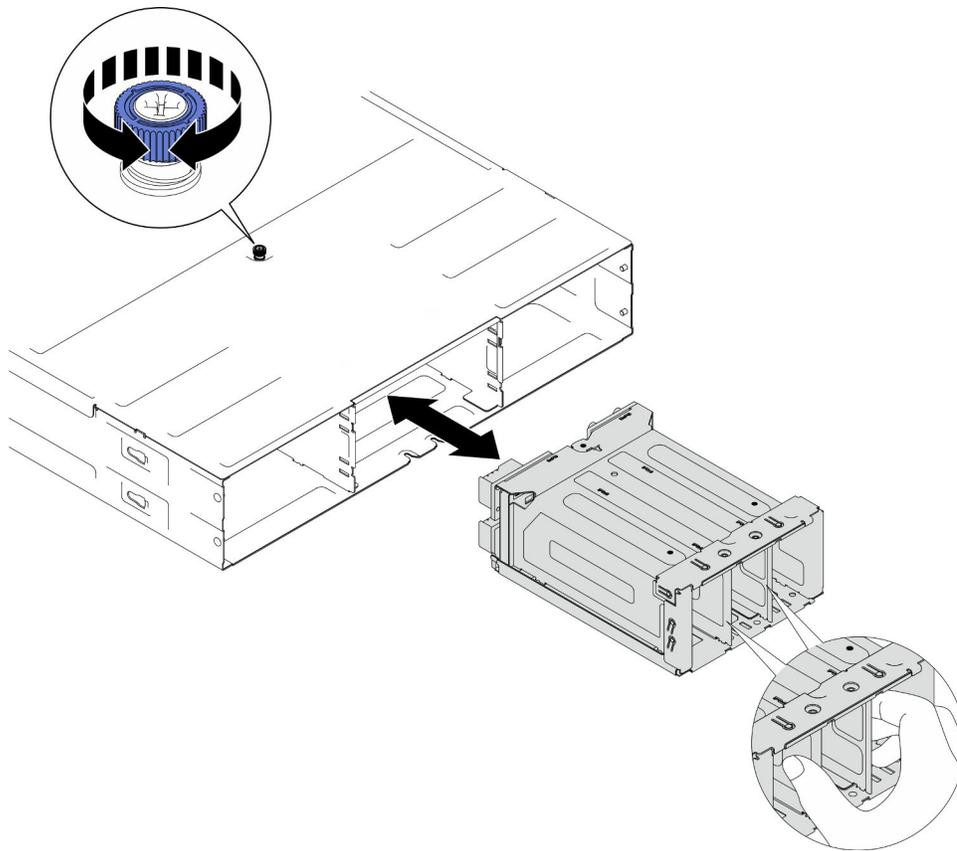
Figura 29. Rimozione del telaio PSU
