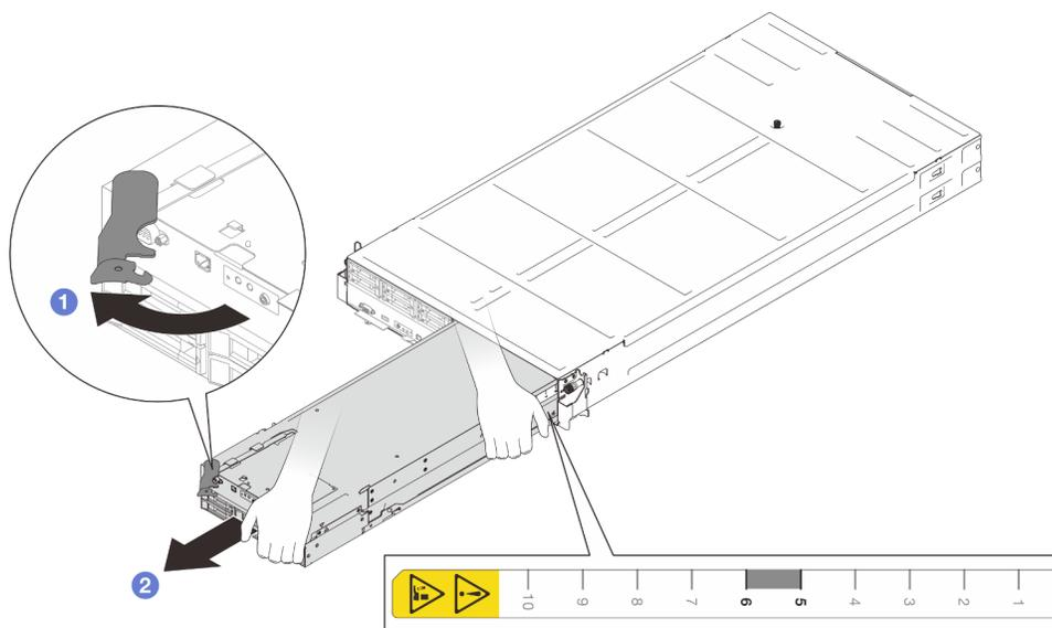
Figura 34. Rimozione del nodo dal vassoio destro
