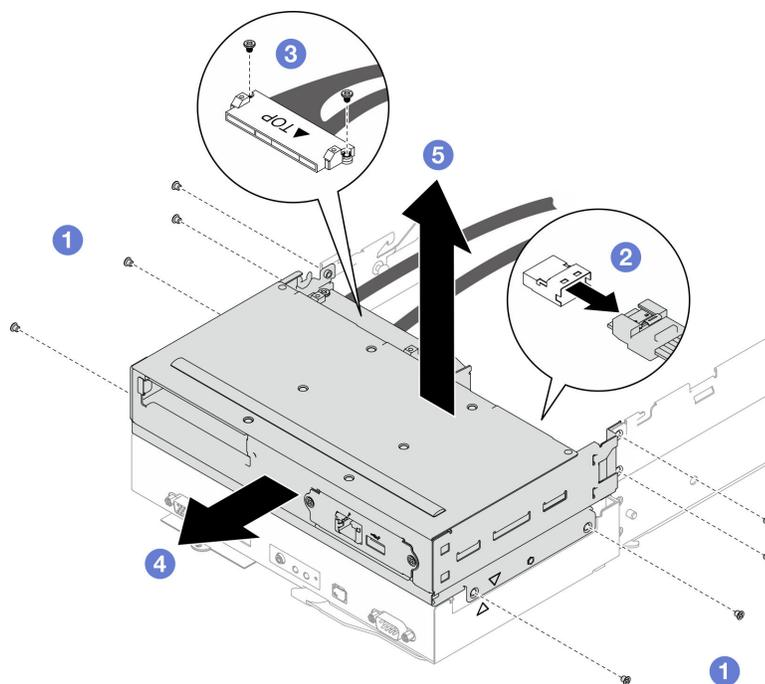
Figura 65. Rimozione del telaio OCP anteriore
