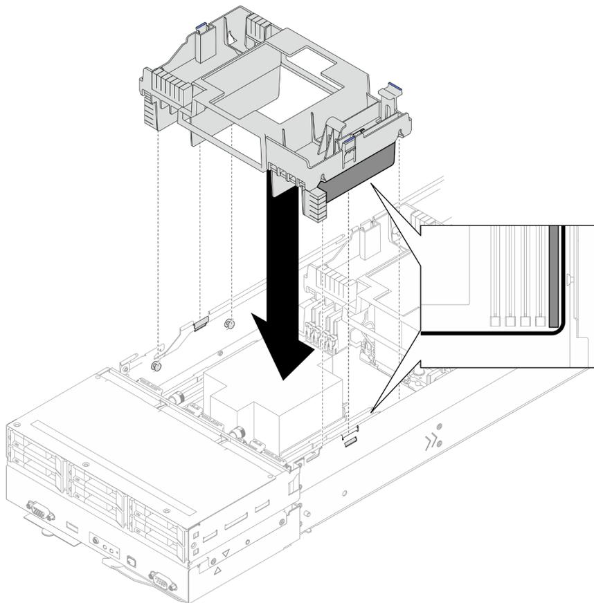
Figura 43. Installazione del deflettore d'aria anteriore
