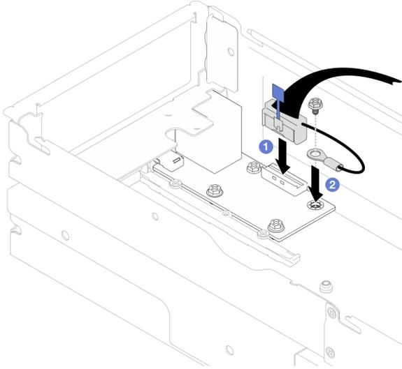
Figura 120. Installazione del cavo I/O posteriore e del cavo di messa a terra
