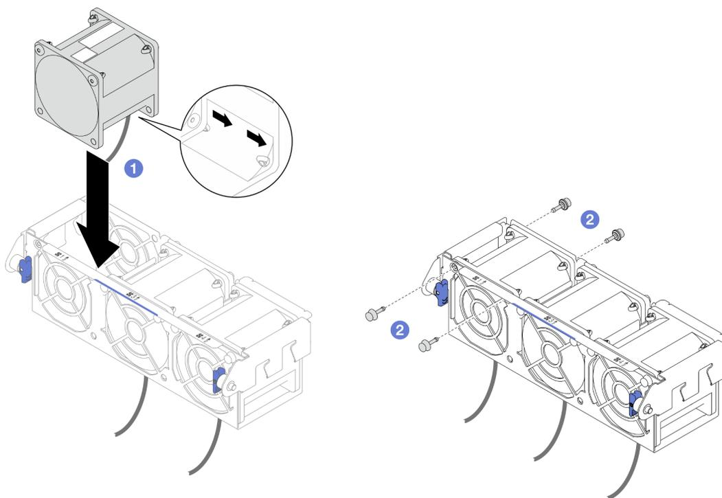
Figura 58. Installazione delle ventole
