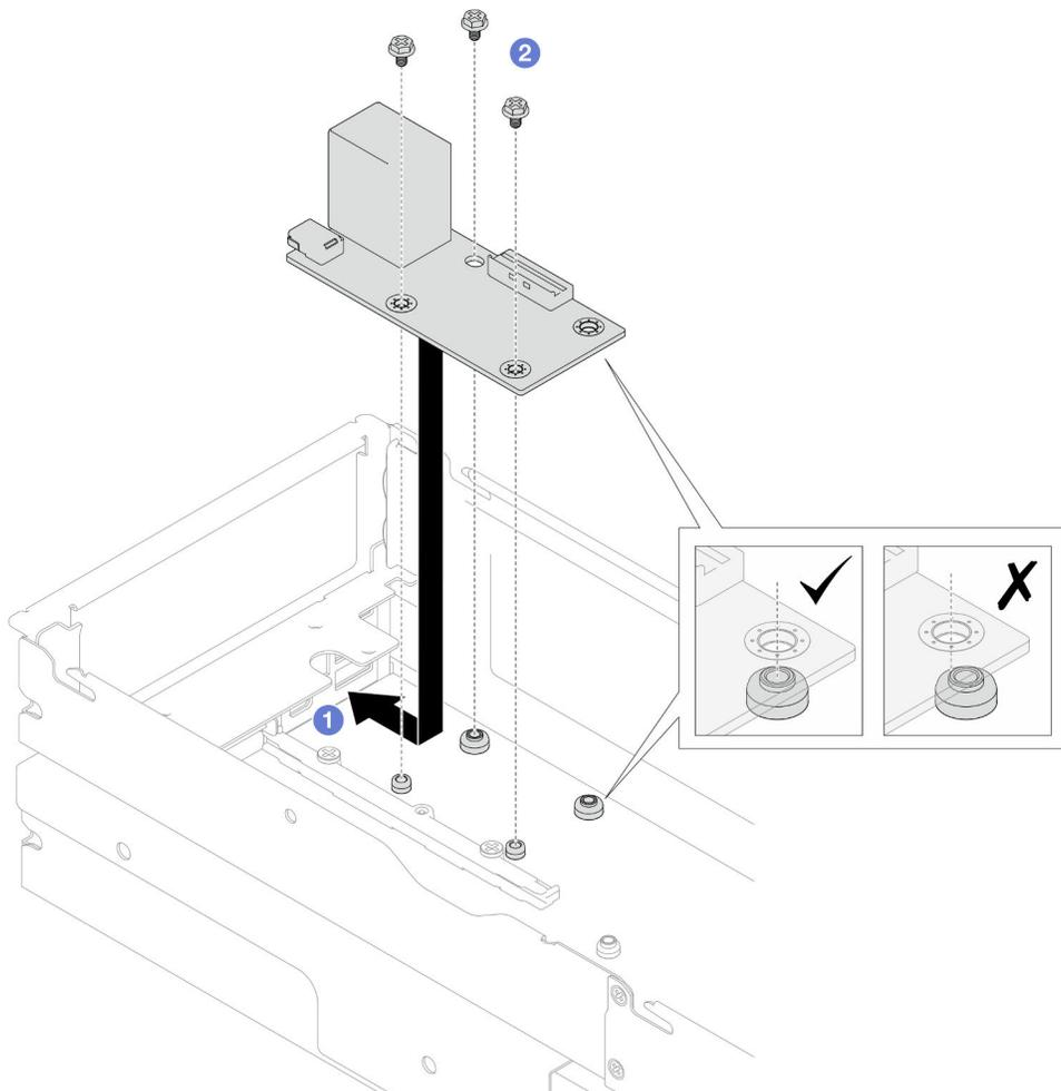
Figura 119. Installazione del modulo I/O posteriore
