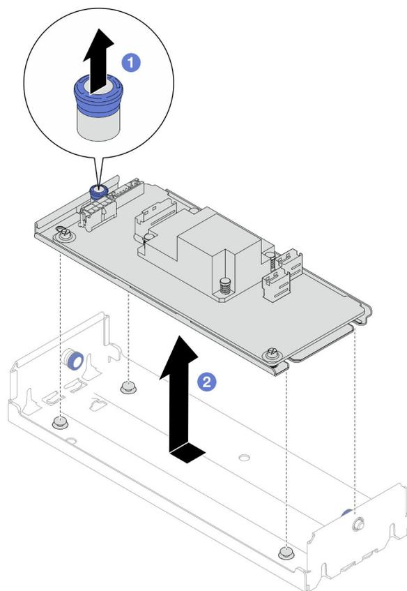
Figura 45. Rimozione dell'adattatore CFF interno
