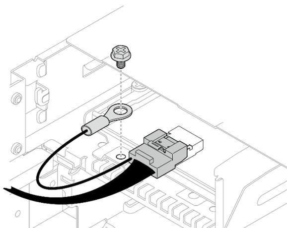
Figura 67. Vite del cavo di messa a terra I/O anteriore
