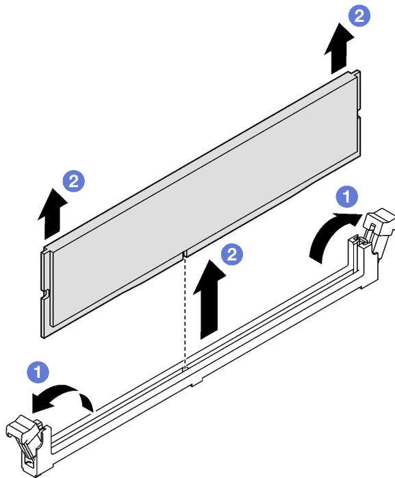
Figura 84. Rimozione di un modulo di memoria
