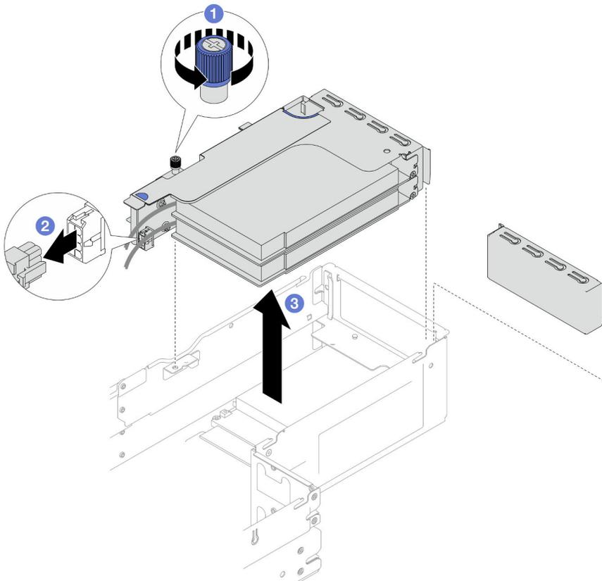
Figura 93. Rimozione dell'assieme verticale PCIe
