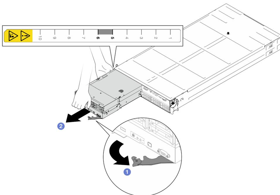
Figura 33. Rimozione del nodo dal vassoio sinistro
