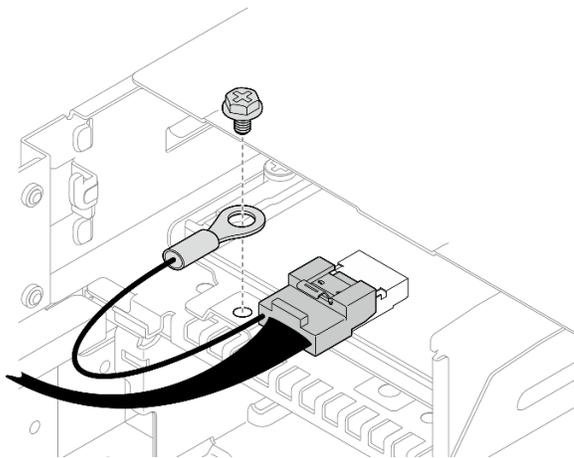
Figura 64. Vite del cavo di messa a terra I/O anteriore
