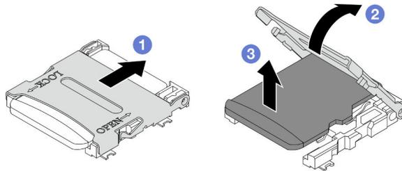
Figura 88. Rimozione della scheda MicroSD
