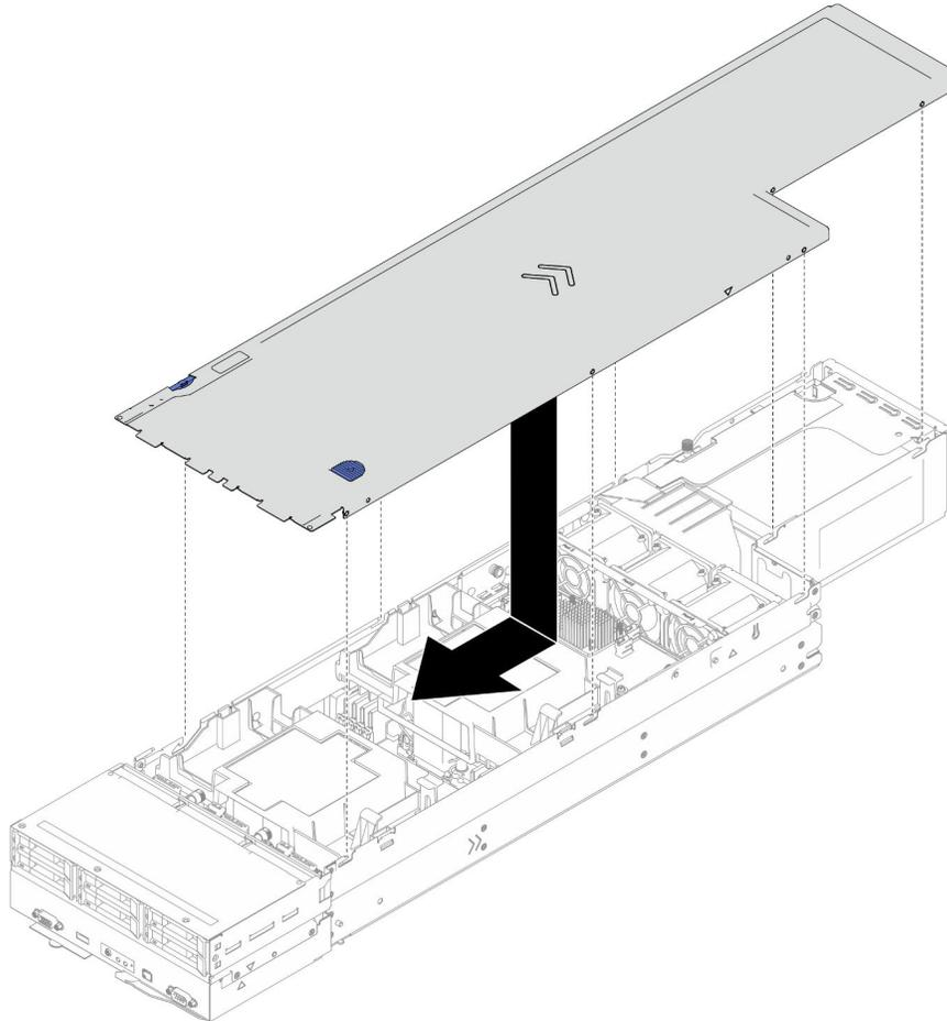
Figura 136. Installazione del coperchio superiore
