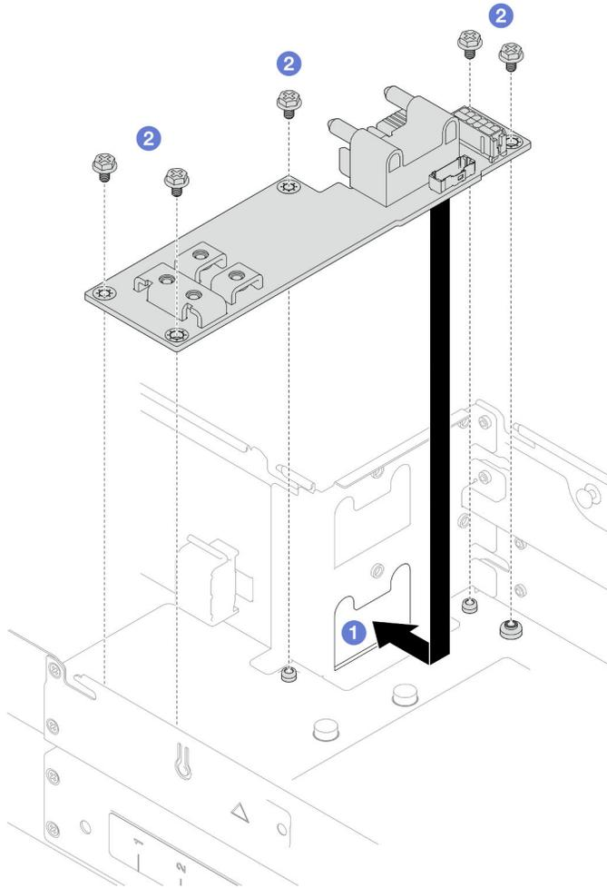
Figura 105. Installazione di una scheda di distribuzione dell'alimentazione
