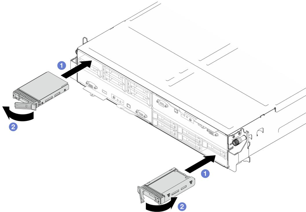
Figura 74. Installazione di un'unità SSD da 7 mm
