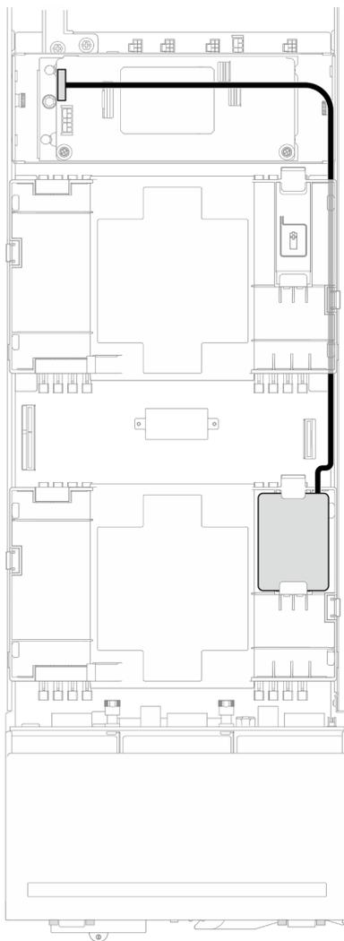
Figura 63. Cavo del modulo di alimentazione flash e RAID CFF
