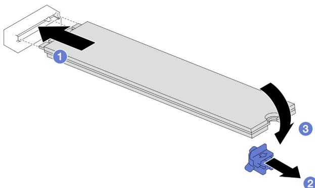
Figura 82. Installazione di un'unità M.2
