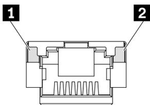
Figura 171. LED Porta di gestione del sistema XCC (10/100/1.000 Mbps RJ-45)
