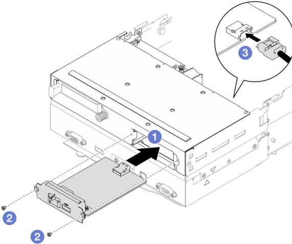
Figura 138. Installazione di un modulo di gestione XCC
