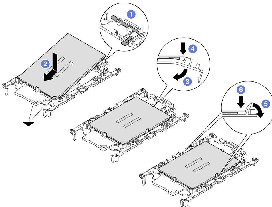
Figura 112. Installazione della piastra del processore
