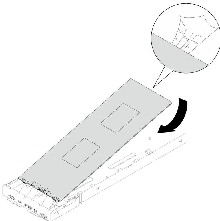
*Figura 131. Installazione della scheda di sistema*
