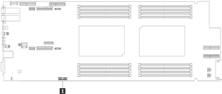
Figura 69. Ubicación de batería CMOS
