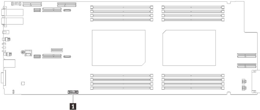
그림 69. CMOS 배터리 위치
