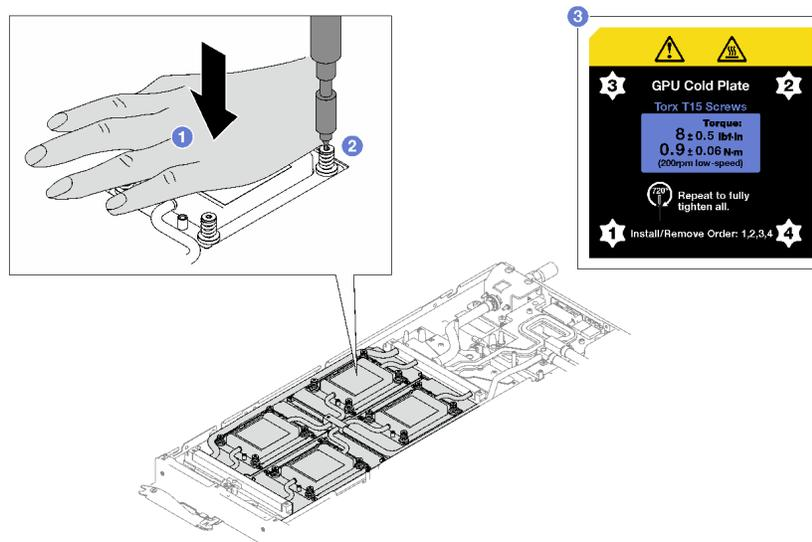
图 293. 将 GPU OAM 冷却板螺钉拧紧 720 度
