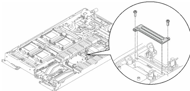
图 66. 安装 VR 夹板
