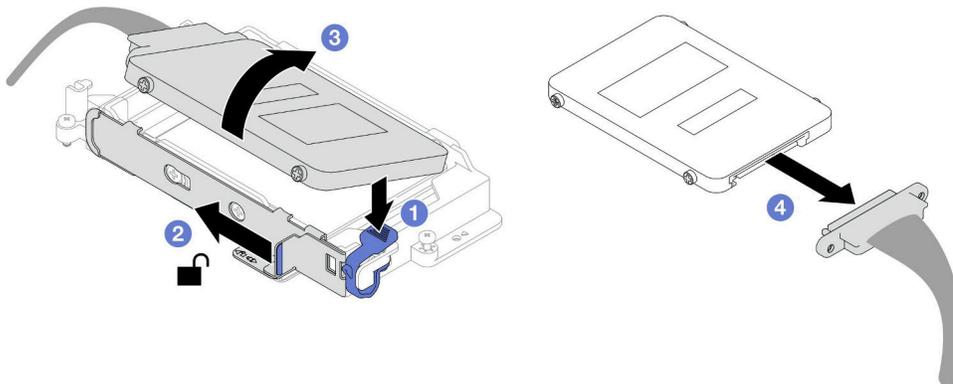
图 102. 卸下上方硬盘 (7 毫米 NVMe)
