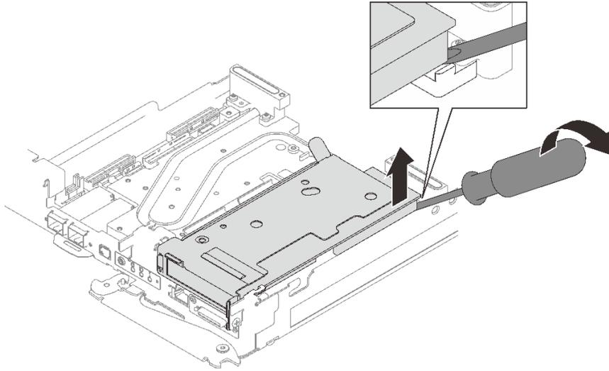
图 191. 将 PCIe 转接卡架从水循环模块冷却板上松开
