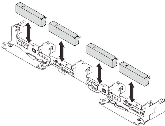
图 90. 卸下空挡板填充件
