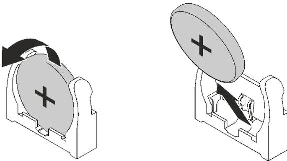
图 68. 卸下 CMOS 电池
