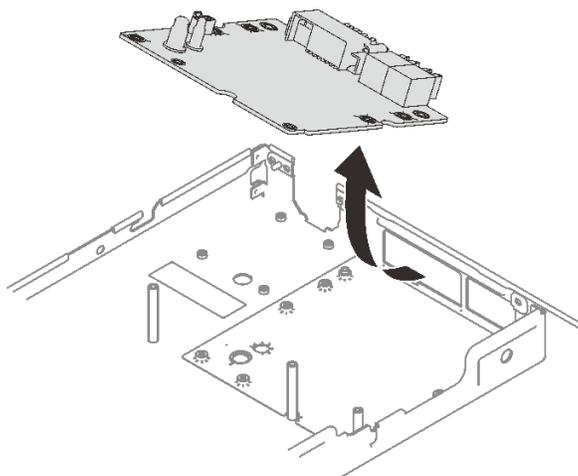
图 305. 卸下 GPU 配电板
