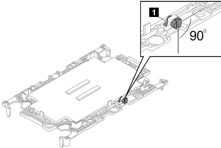
图 44. 处理器固定器上的 TIM 断开凸轮
