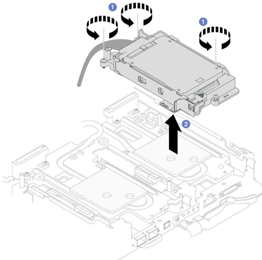
图 100. 卸下 7 毫米 NVMe 硬盘仓组合件
