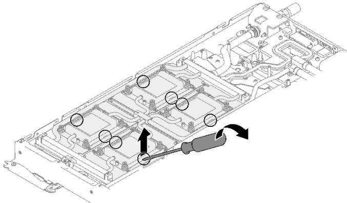
图 260. 从 GPU OAM 上卸下 GPU OAM 冷却板
