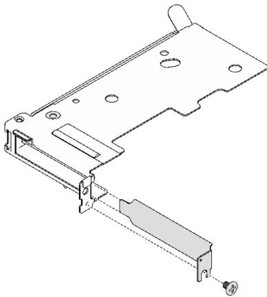
图 161. 安装填充件
