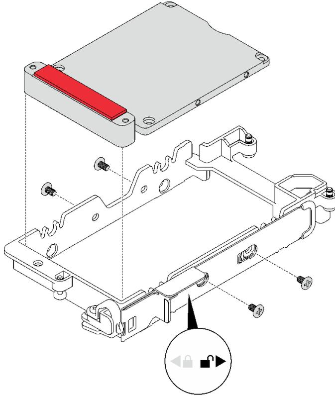
图 87. 安装导电板
