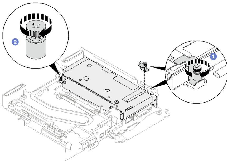
图 175. 安装夹持支架的松不脱螺钉
