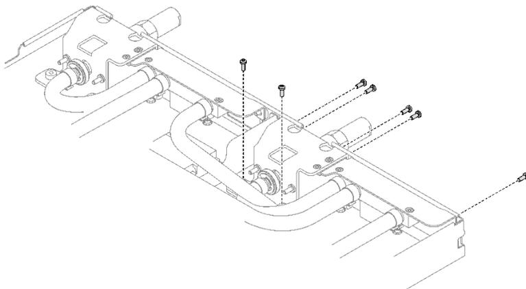
图 218. 安装快接件螺钉
