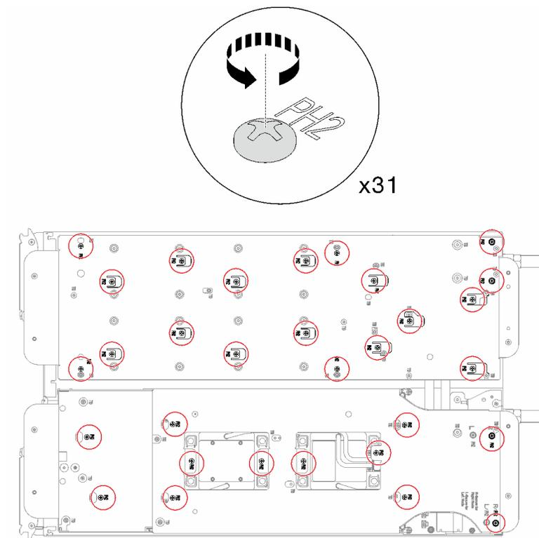
图 59. 拧松水循环模块载板的螺钉
