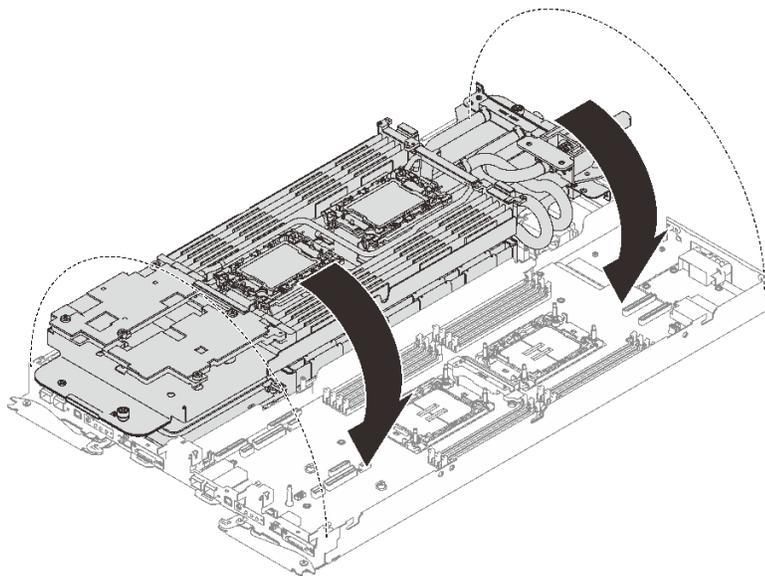
图 240. 安装水循环模块
