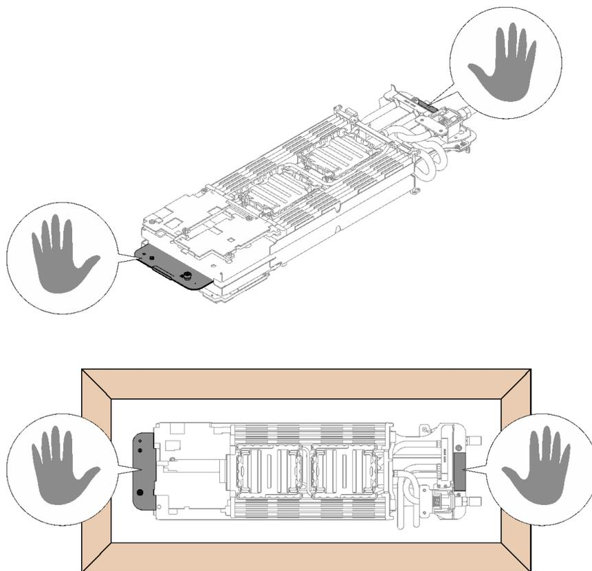
图 45. 从包装盒中取出水循环模块时的操作点
