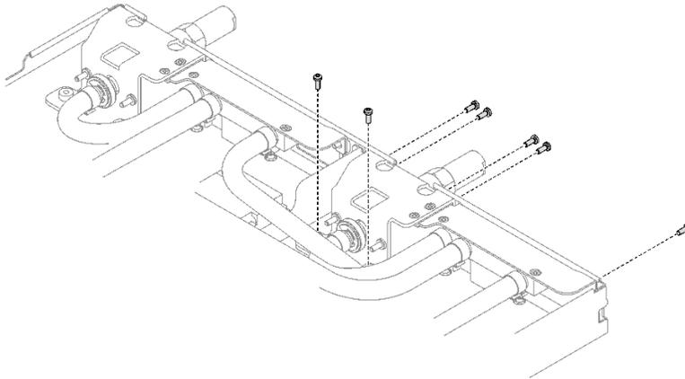
图 223. 卸下快接件螺钉
