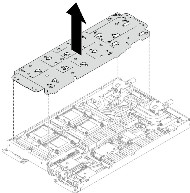
图 272. 卸下水循环模块载板
