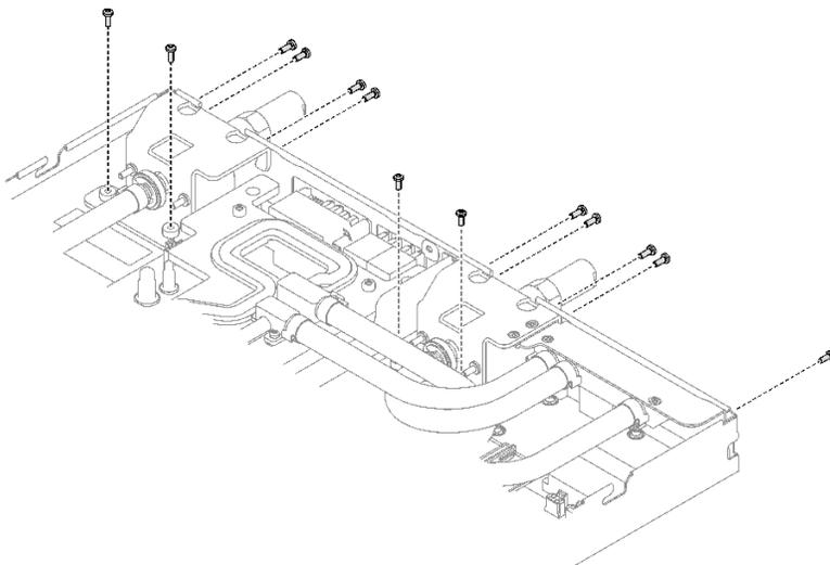
图 27. 卸下快接件螺钉
