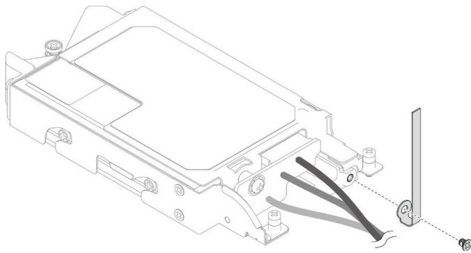
图 129. 安装线缆扎带
