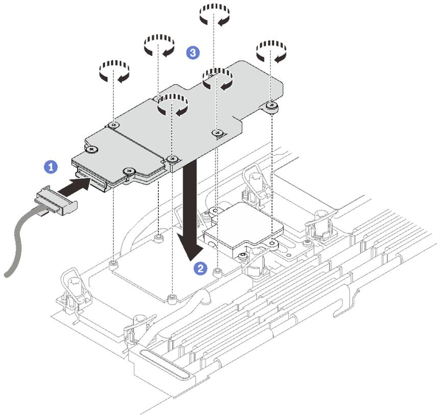
图 147. 安装 M.2 背板组合件
