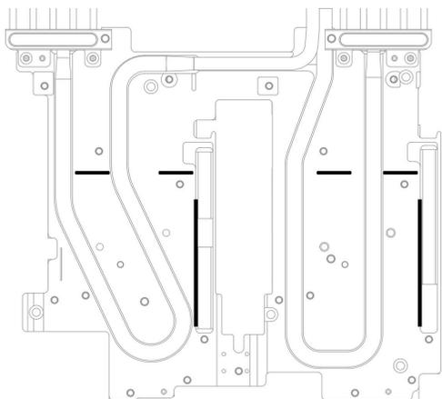
图 132. 水循环模块上的 E3.S 间隙垫对齐标记
