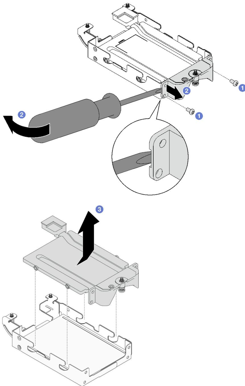
图 121. 卸下导电板
