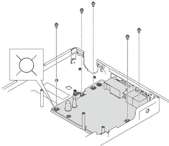
图 308. 安装螺钉
