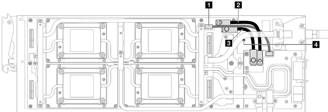
图 321. SD650-I V3 托盘电源线布放
