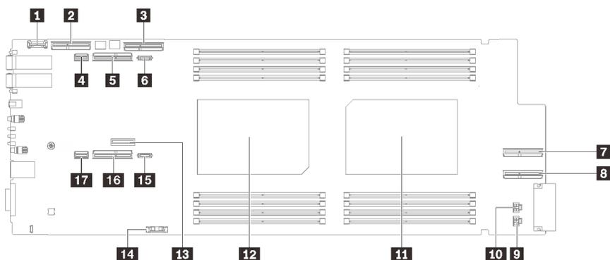
图 6. 计算节点主板上的内部接口
