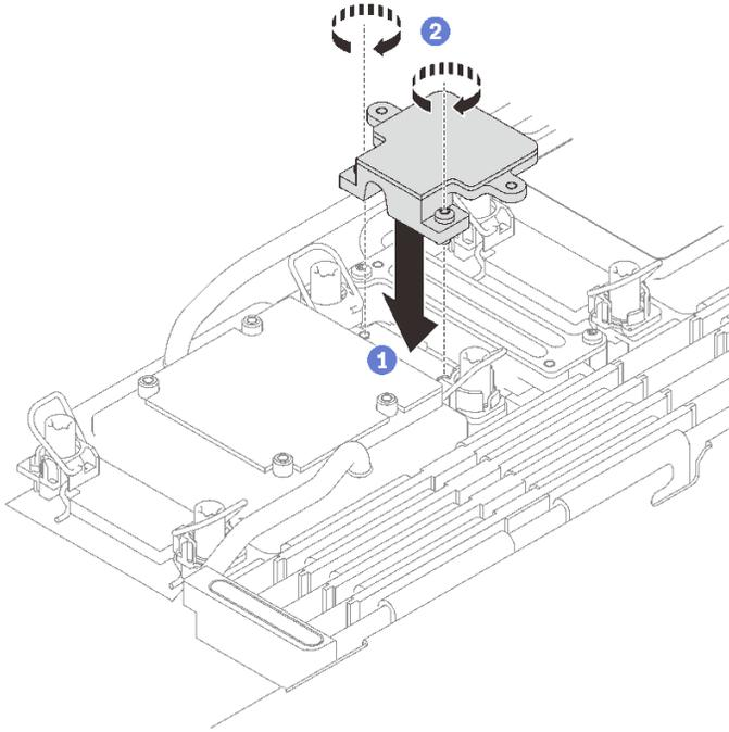
步骤 3. 更换处理器（处理器 1）冷却板和 M.2 背板冷却板上的油灰垫。请确保遵循[间隙垫/油灰垫更换准则](#)。
