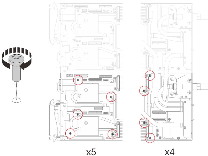
图 217. 安装水循环模块螺钉
