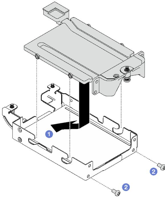
图 126. 安装 E3.s 硬盘导电板
