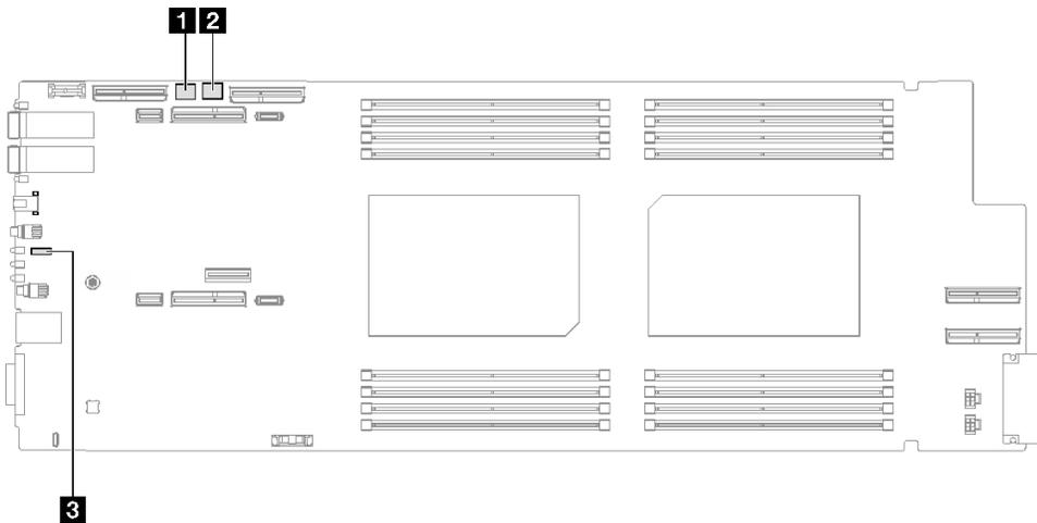
图 8. 计算节点主板上的开关
