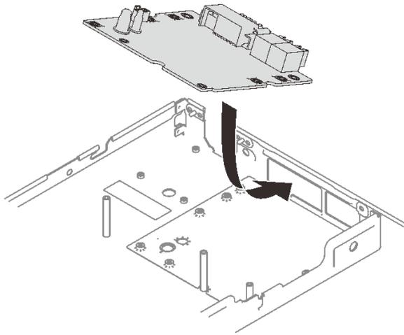
图 307. 安装 GPU 配电板
