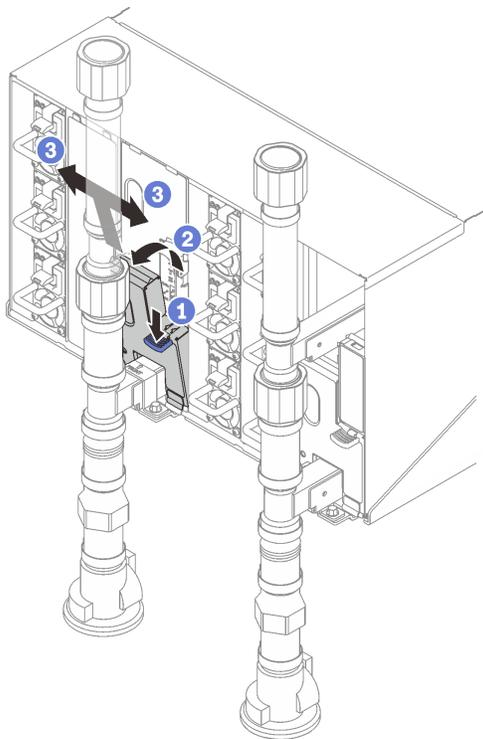
图 333. 卸下下方 EMC 保护罩
