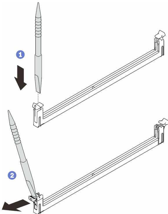
图 156. 按下内存条插槽上的固定夹
