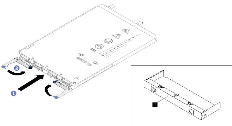
图 19. 安装托盘
