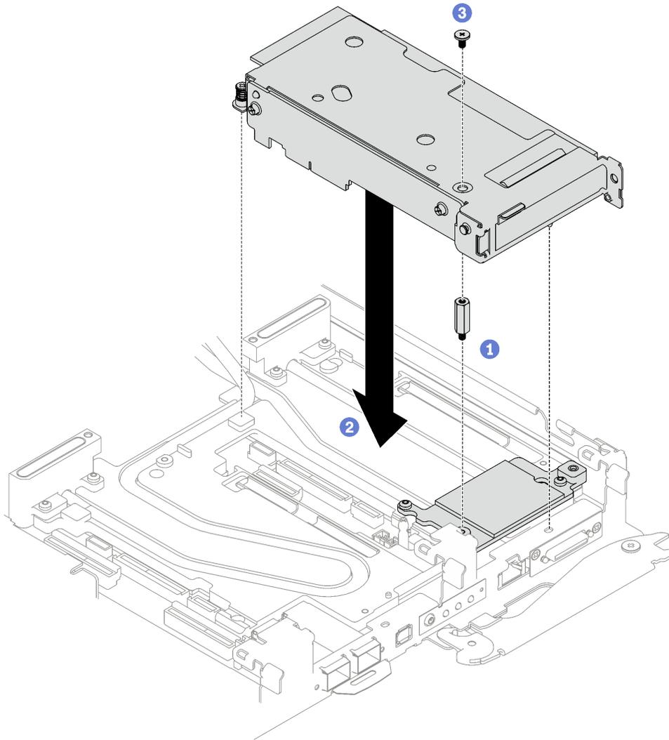
图 174. 安装 PCIe 转接卡组合件
