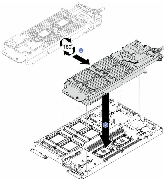
图 53. 安装水循环模块载板
