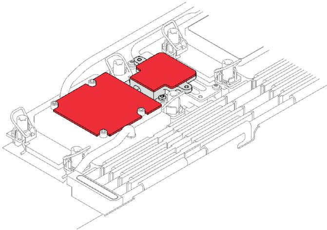
图 146. 处理器冷却板和 M.2 背板冷却板上的间隙垫
