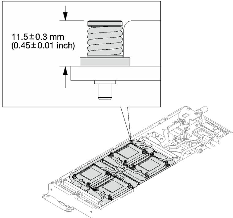
图 294. 正确安装的 GPU OAM 冷却板螺钉的高度
