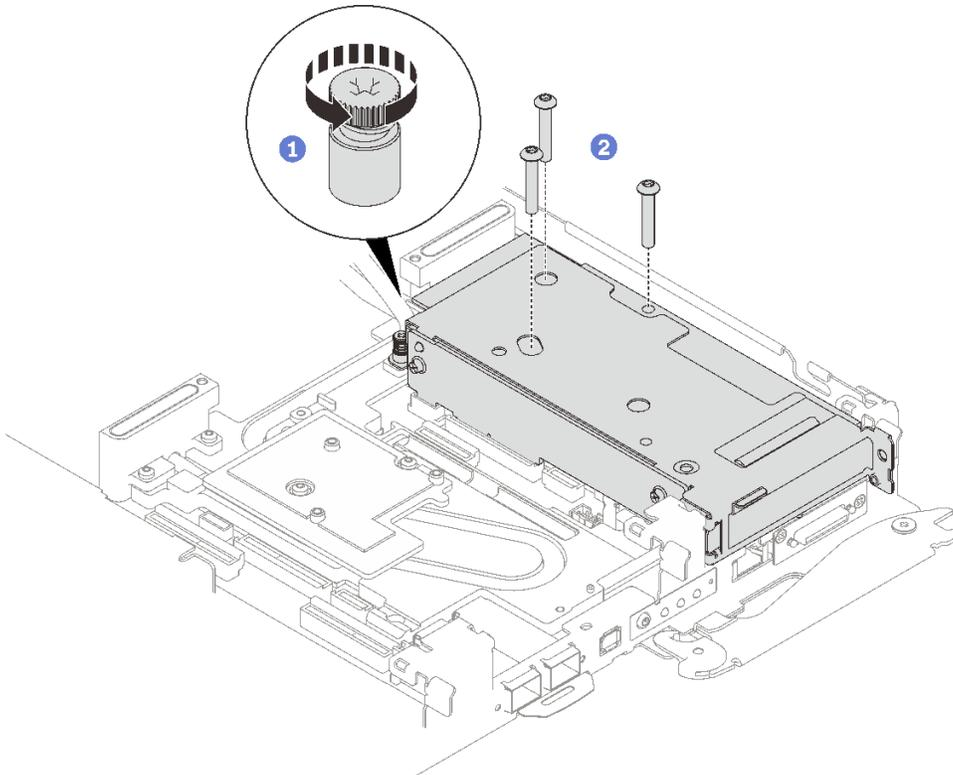
图 190. 卸下 PCIe 转接卡组合件
