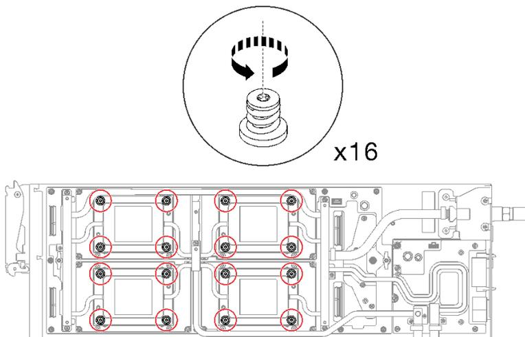
图 258. 卸下 GPU OAM 冷却板螺钉
