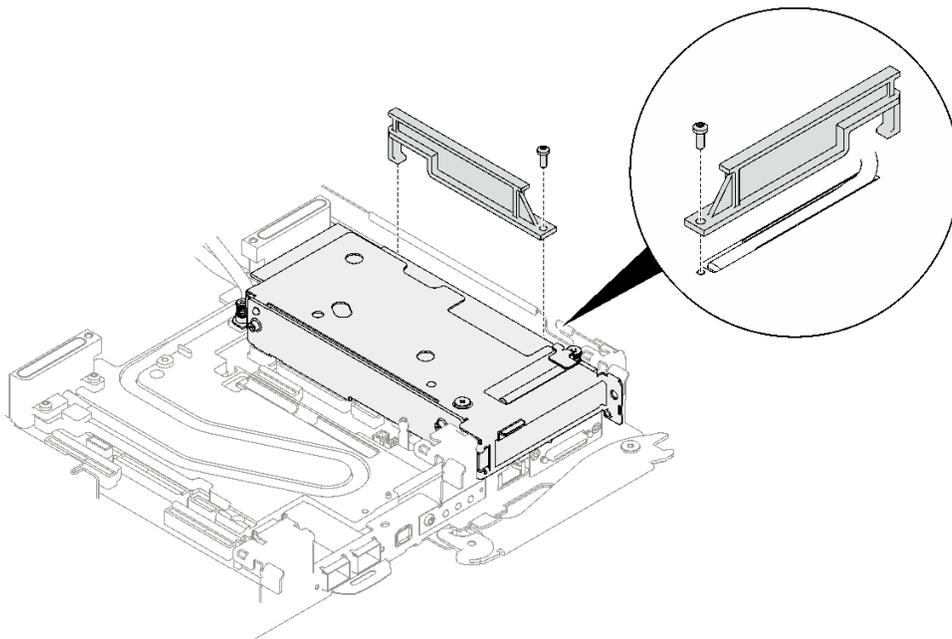
图 165. 卸下导热管架
