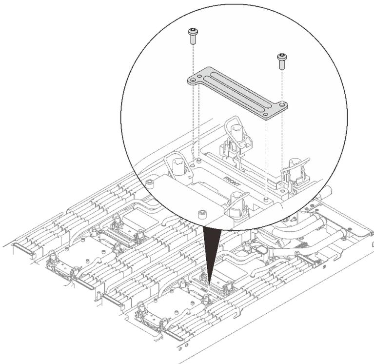
图 219. 安装 VR 夹板
