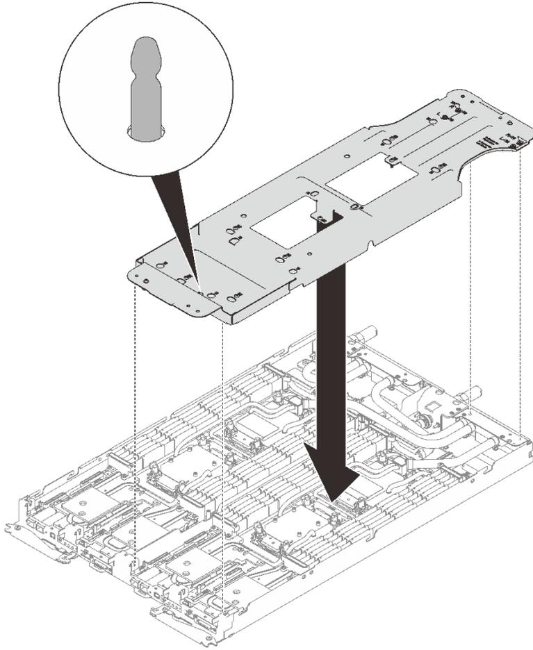
图 224. 安装水循环模块载板
