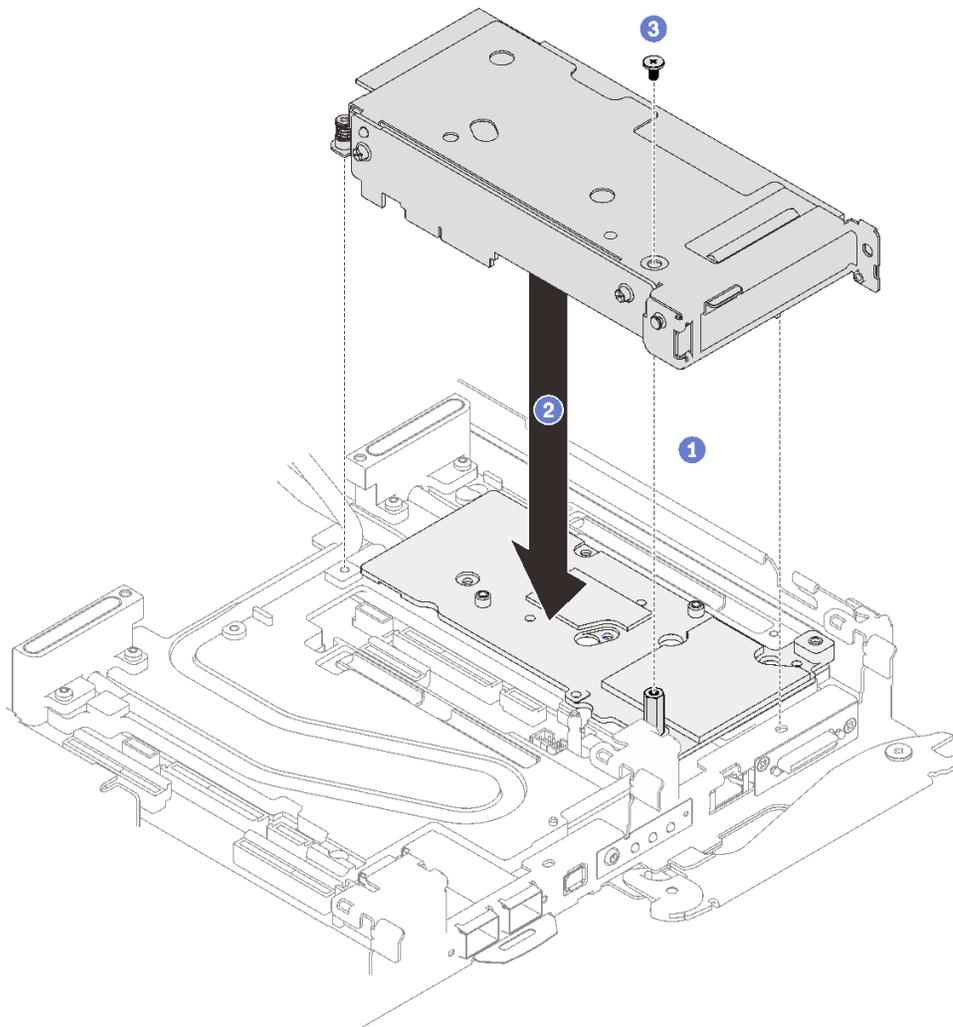
图 188. 安装 PCIe 转接卡组合件
