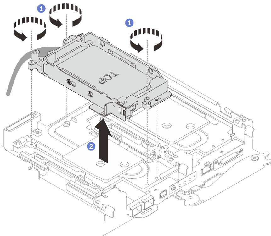
图 77. 卸下单 7 毫米硬盘仓组合件
