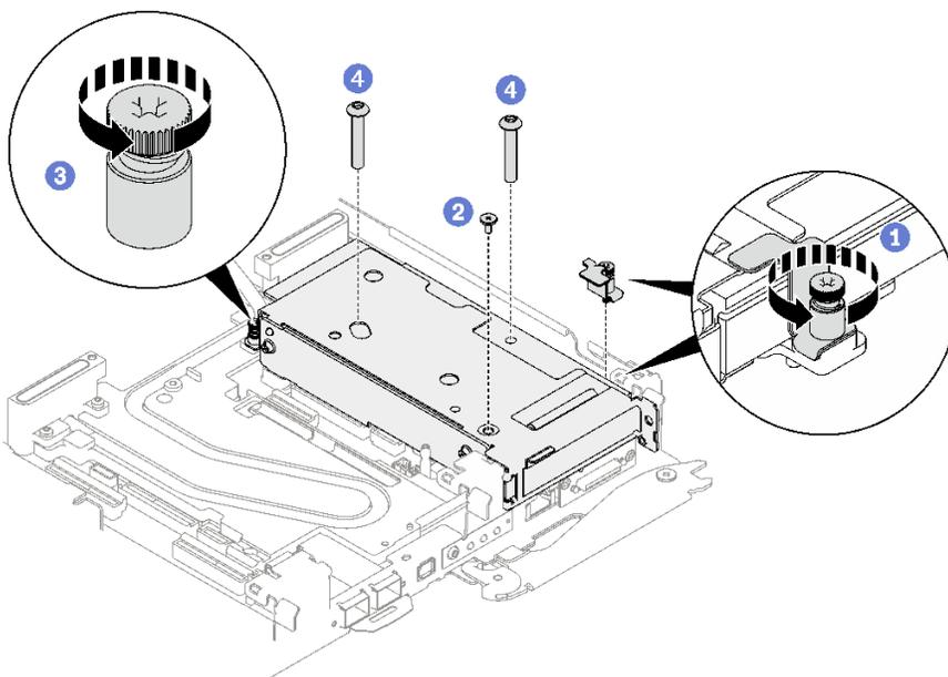
图 177. 卸下夹持支架的松不脱螺钉
