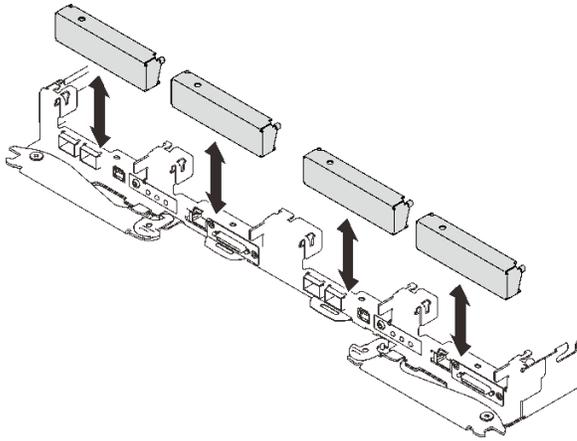
图 197. 安装空挡板填充件
