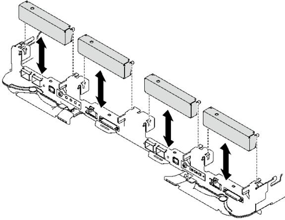
图 108. 安装空挡板填充件
