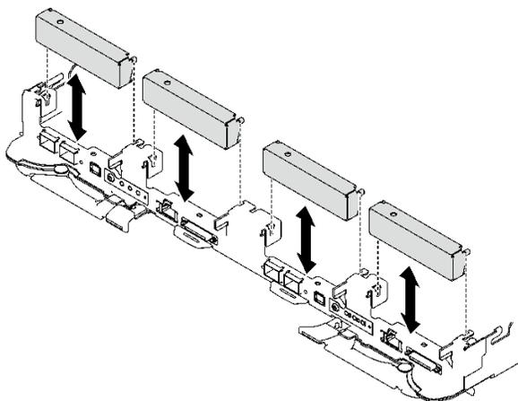
图 101. 卸下空挡板填充件
