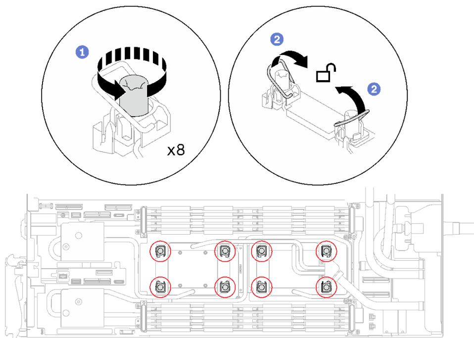
图 32. 拧松内六角 T30 松不脱螺钉
