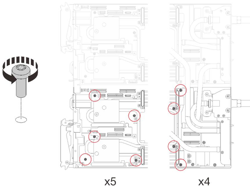
图 204. 卸下水循环模块螺钉
