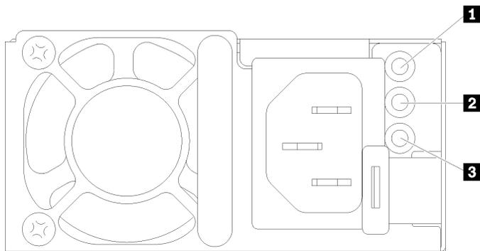
图 328. 交流电源模块 LED
