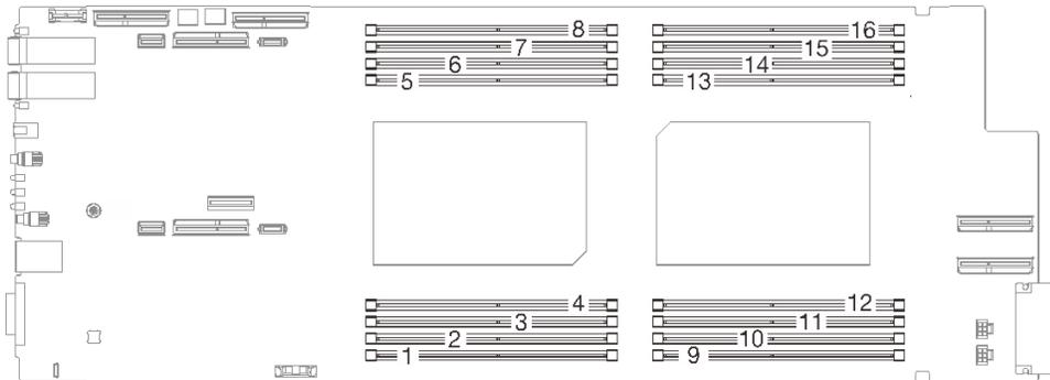
图 7. 计算节点主板上的 DIMM 插槽编号
