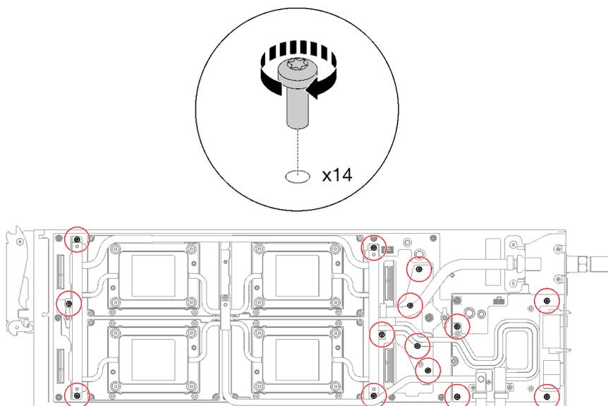
图 290. 安装水循环模块螺钉
