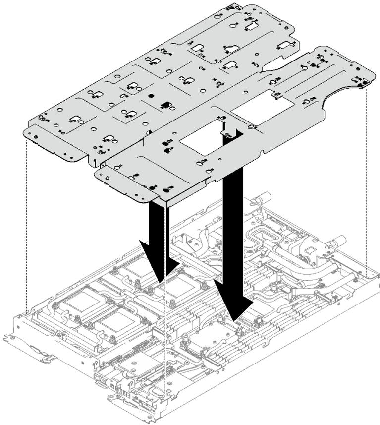
图 33. 安装水循环模块载板
