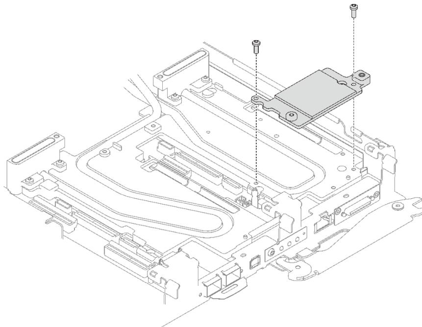
图 172. 安装接口板
