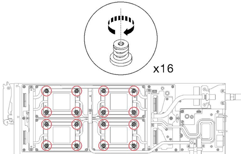
图 292. 安装 GPU OAM 冷却板螺钉
