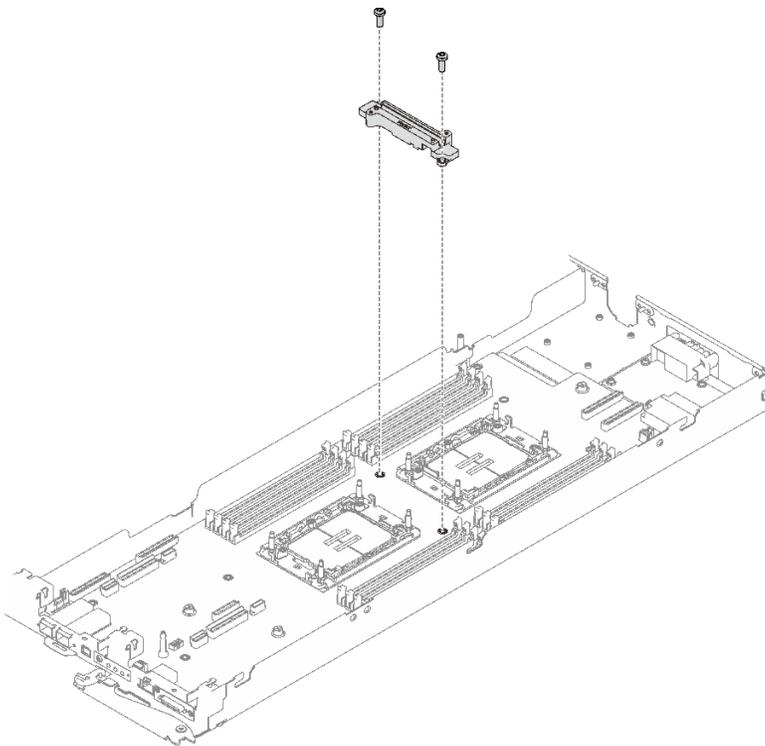
图 254. 安装 VR 水循环模块槽
