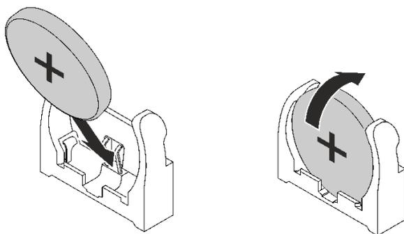
图 70. 安装 CMOS 电池
