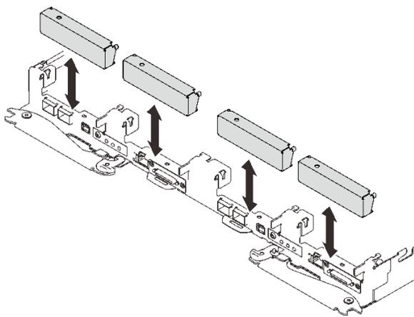
图 131. 安装空挡板填充件
