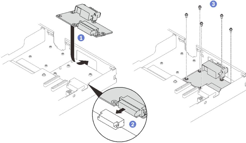
图 211. 安装配电板
