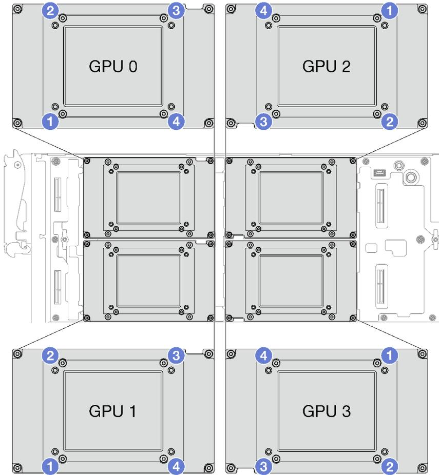
图 283. 安装 GPU OAM 时的螺钉拧紧顺序
