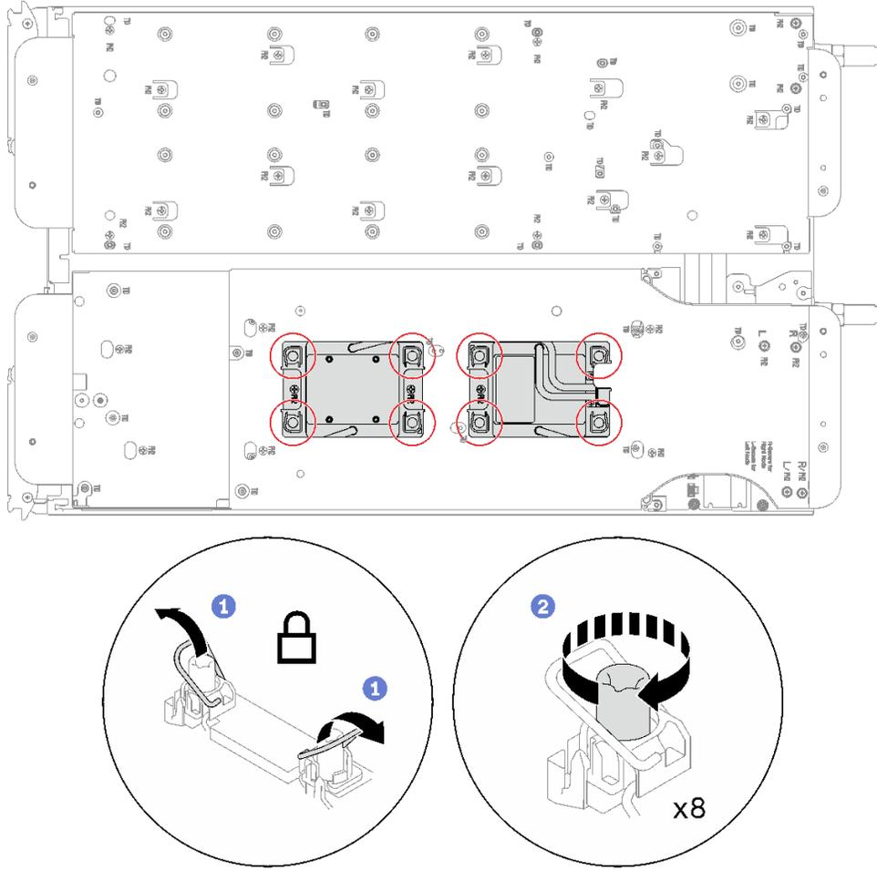
图 58. 拧紧内六角 T30 松不脱螺钉
