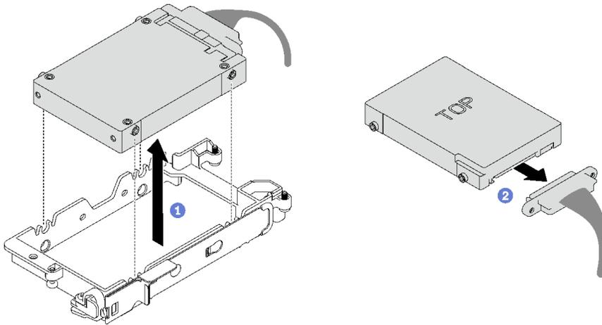
图 81. 卸下 15 毫米硬盘
