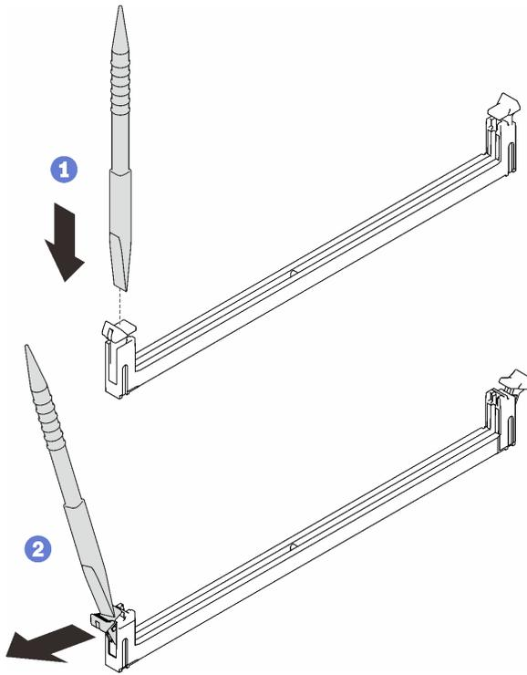
图 151. 按下内存条插槽上的固定夹
