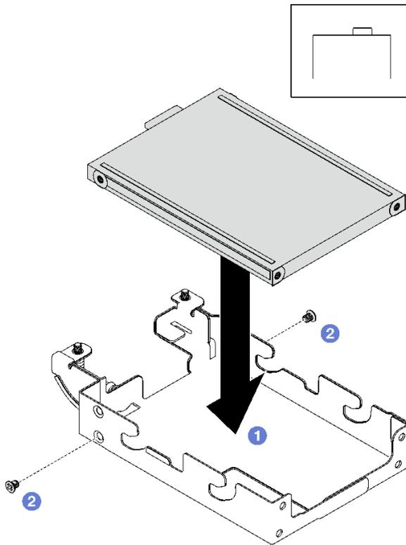
图 123. 安装顶部 E3.S 硬盘
