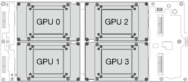
图 10. GPU OAM 编号 - SD650-I V3 托盘
