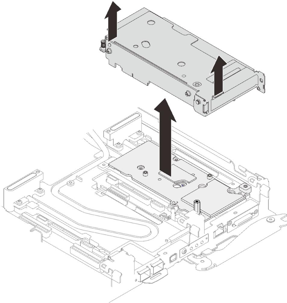
图 178. 卸下 PCIe 转接卡组合件
