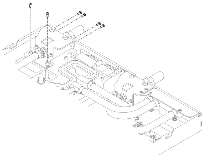
图 291. 安装快接件螺钉
