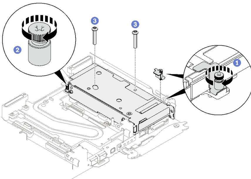
图 189. 安装夹持支架的松不脱螺钉
