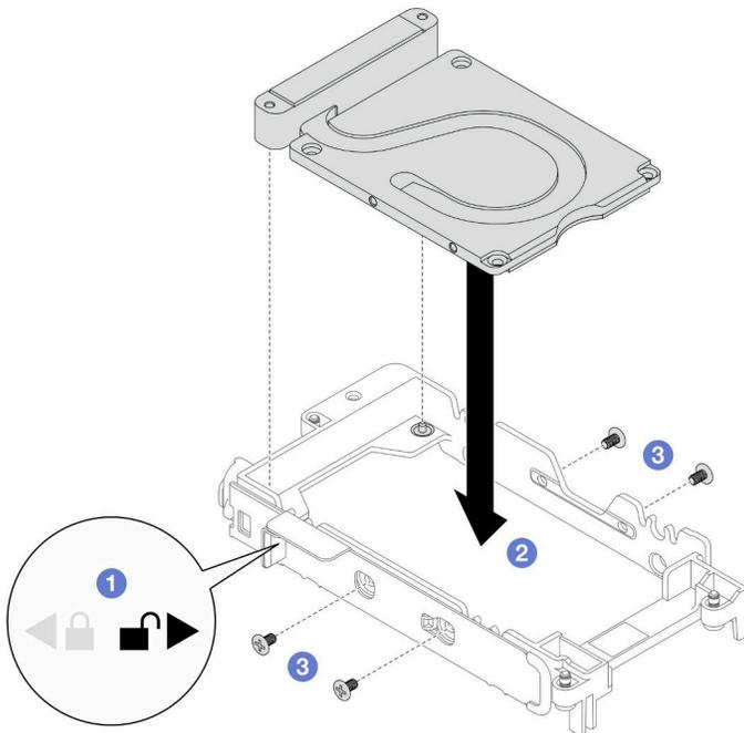
图 105. 安装导电板
