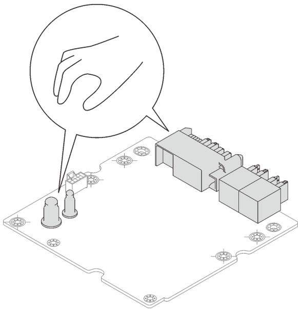
图 295. SD650-I V3 GPU 配电板操作点
