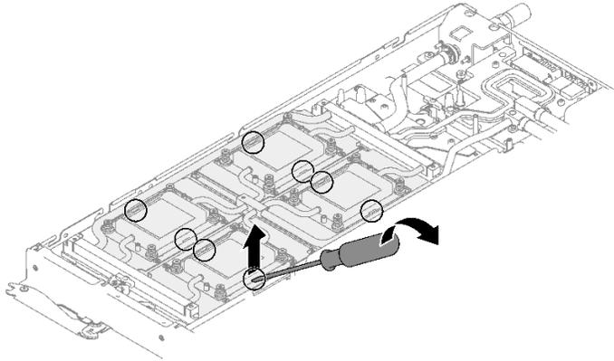
图 300. 从 GPU OAM 上卸下 GPU OAM 冷却板
