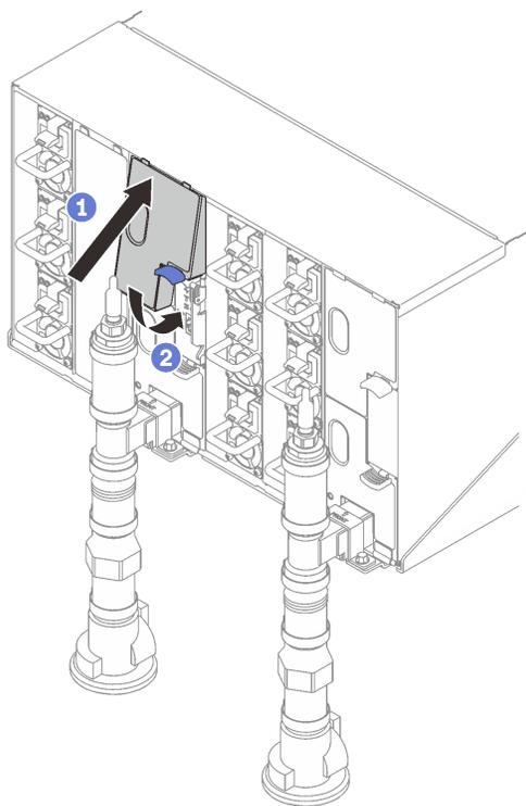
图 335. 安装上方 EMC 保护罩
