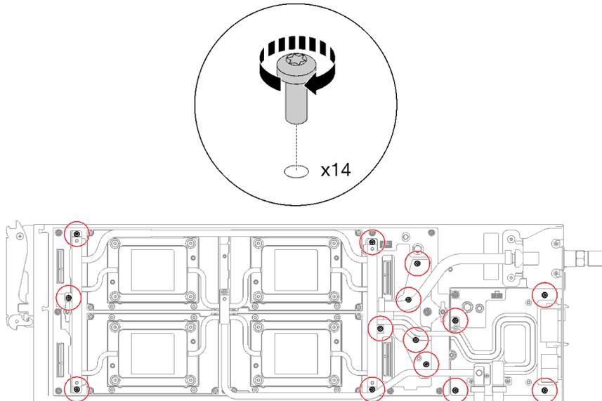
图 315. 安装水循环模块螺钉
