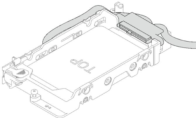
步骤 2. 如果要安装两个 7 毫米硬盘，请完成以下步骤。
