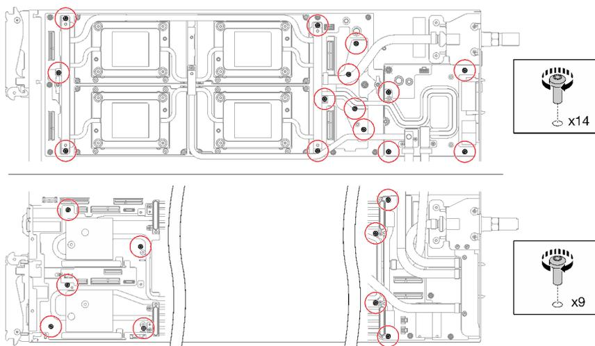
图 61. 安装水循环模块螺钉
