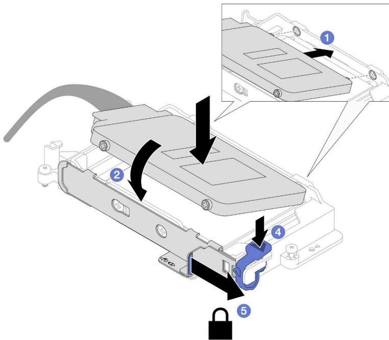
图 107. 安装上方硬盘
