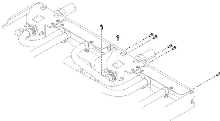
图 205. 卸下快接件螺钉
