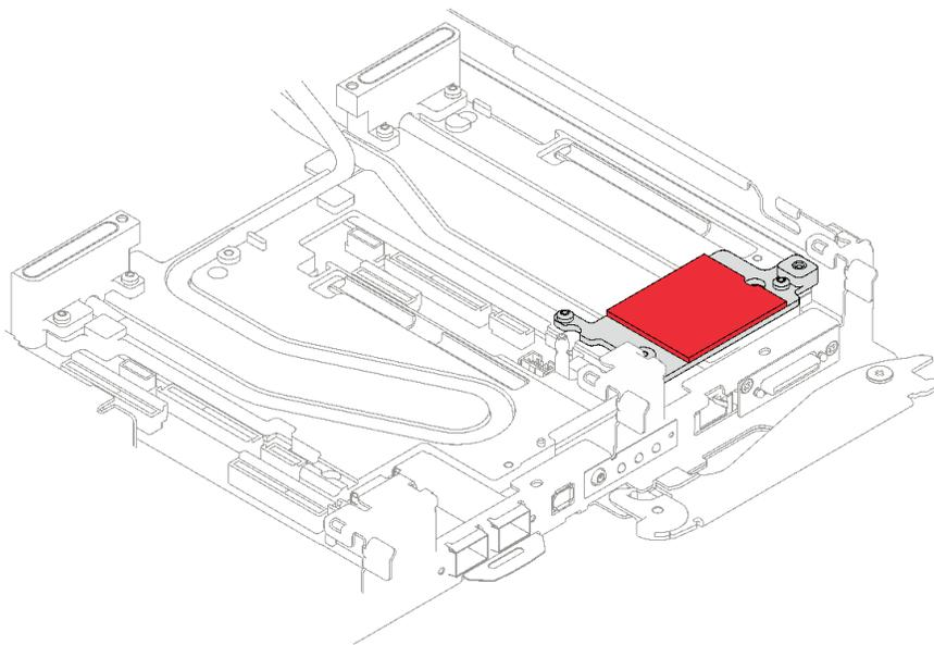
图 173. 适用于 CX-6 转接卡的接口板油灰垫
