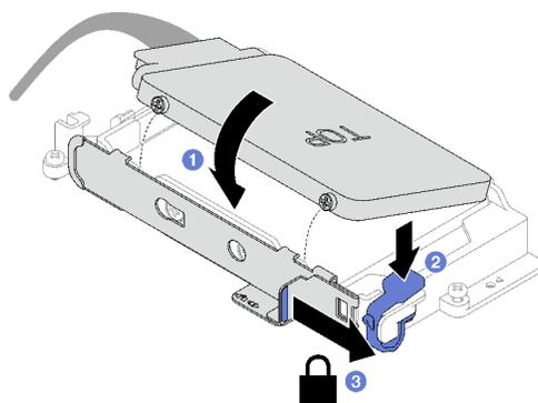
图 89. 安装上方硬盘
