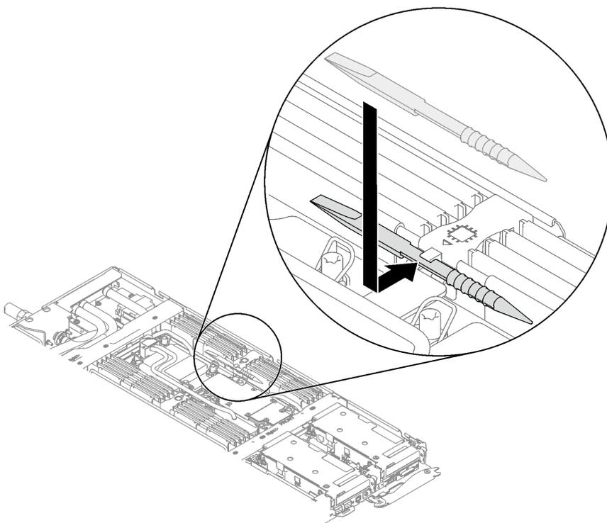
图 74. 安装内存条工具
