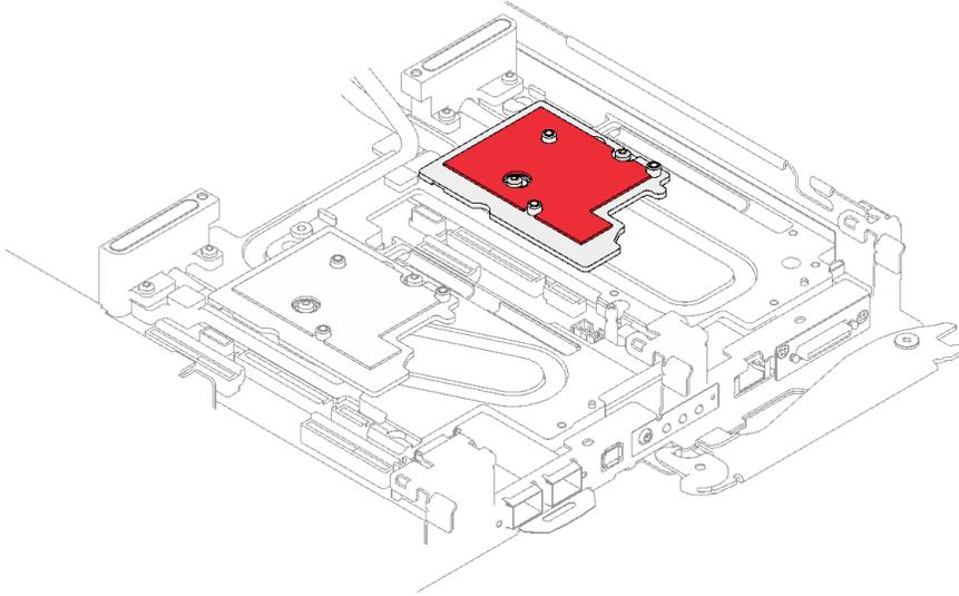
图 201. 适用于 CX-7 NDR 400 的接口板间隙垫
