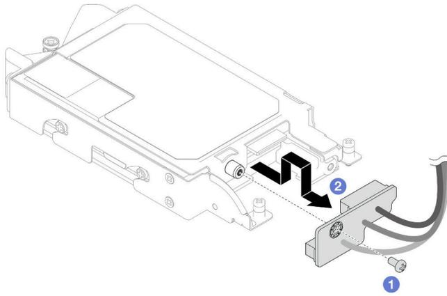
图 119. 卸下 E3.S 硬盘线缆端背板
