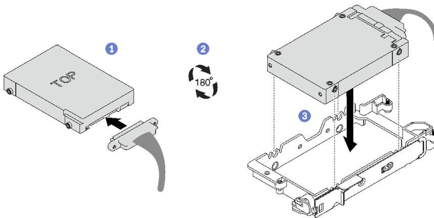
图 86. 安装 15 毫米硬盘
