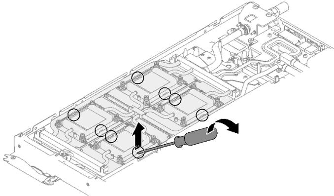
图 31. 从 GPU OAM 上卸下 GPU OAM 冷却板
