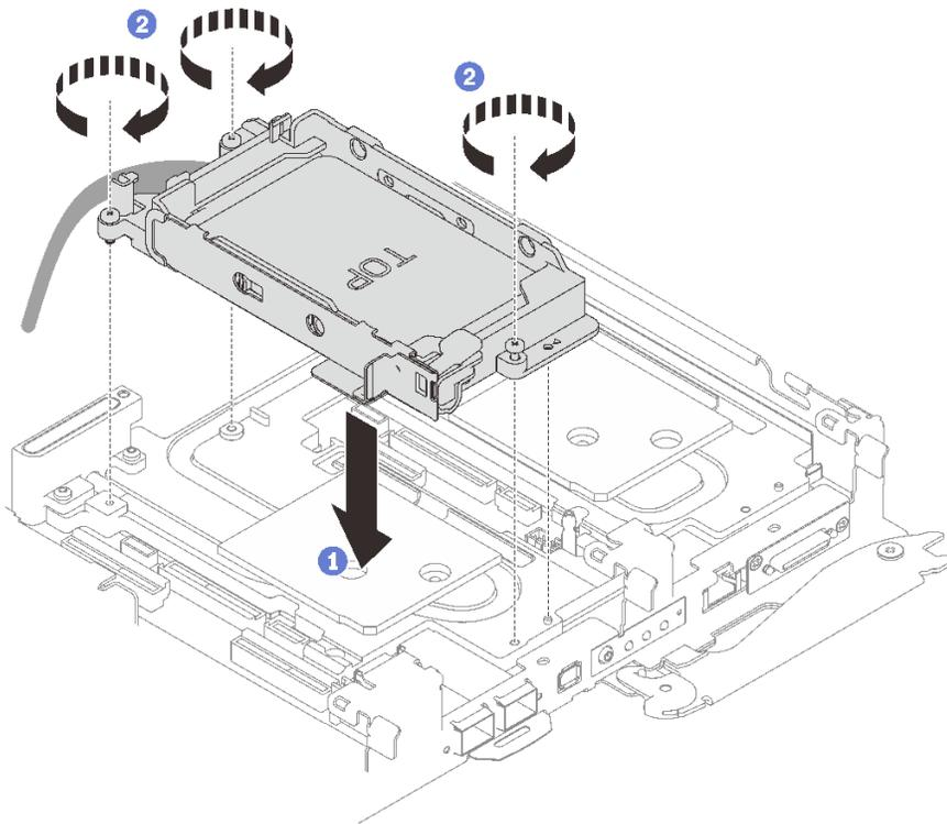
图 96. 安装单 7 毫米硬盘仓组合件
