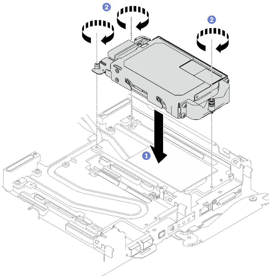
图 134. 安装 E3.s 硬盘仓组合件
