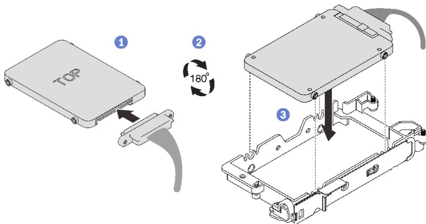
图 88. 安装下方硬盘
