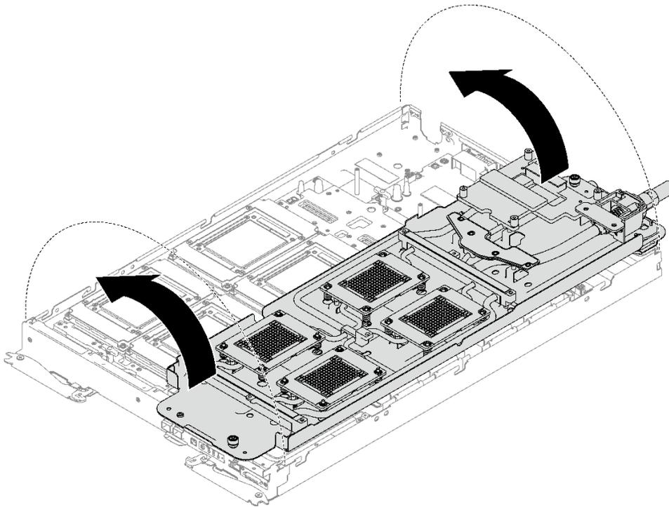
图 312. 安装水循环模块
