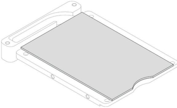
图 104. 安装导电板间隙垫
