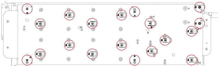
图 262. 安装水循环模块载板的螺钉
