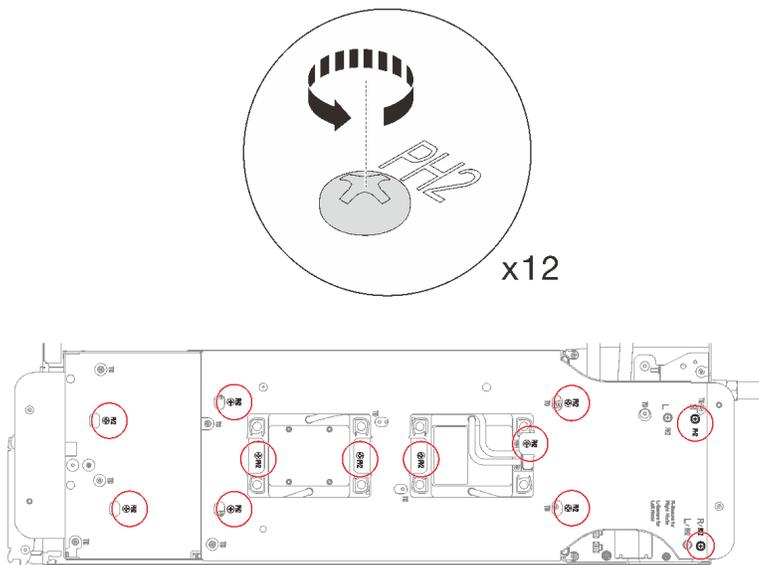
图 215. 拧松水循环模块载板的螺钉
