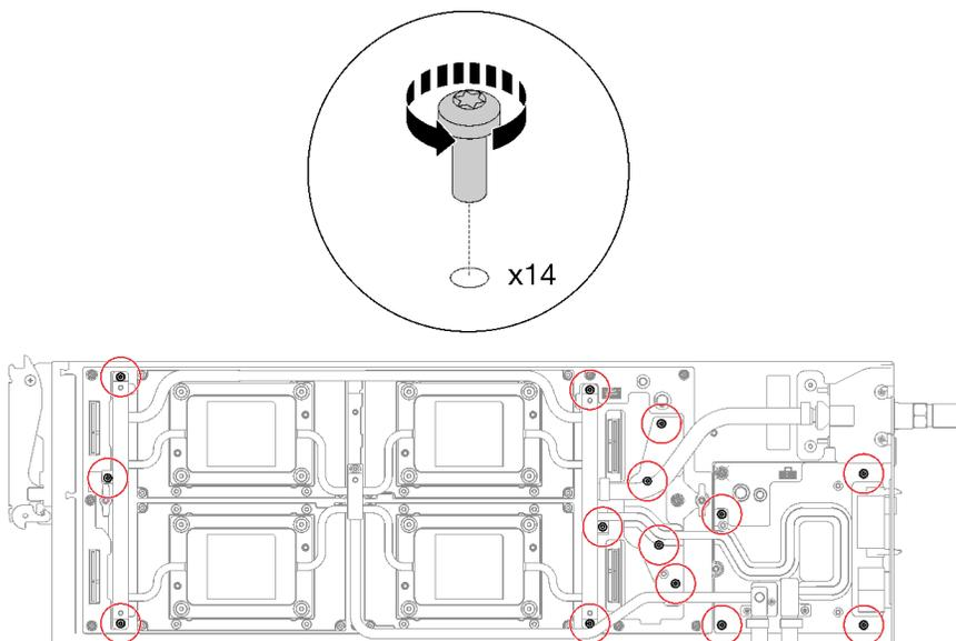
图 297. 卸下水循环模块螺钉
