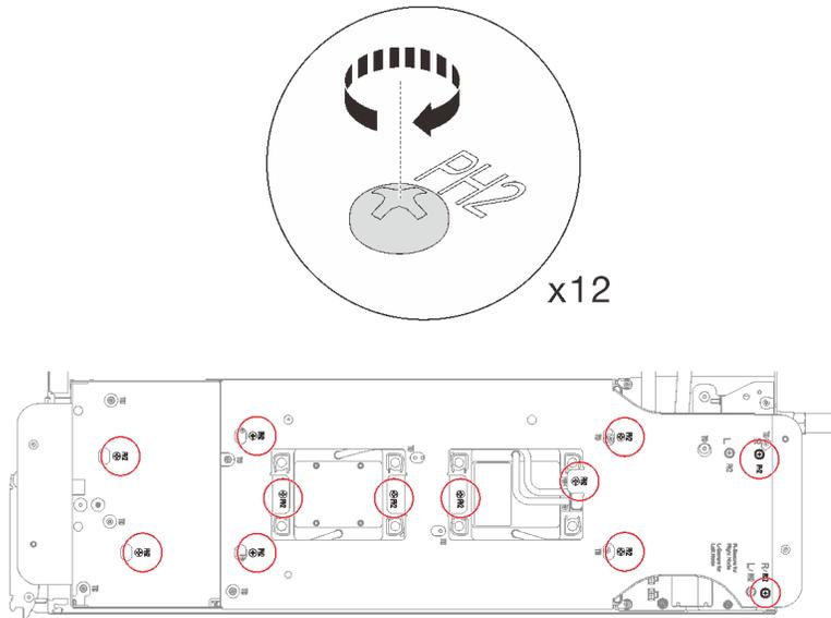
图 225. 安装水循环模块载板的螺钉
