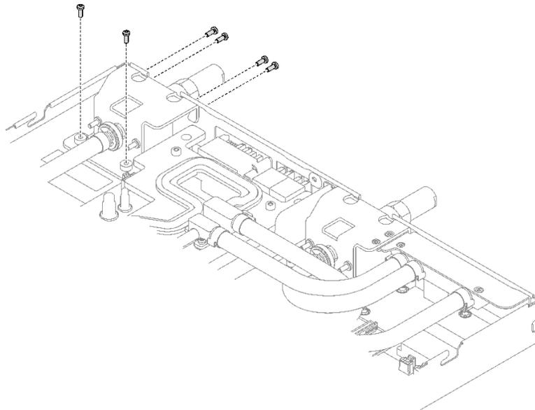
图 316. 安装快接件螺钉
