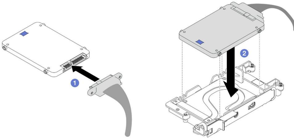
图 106. 安装下方硬盘
