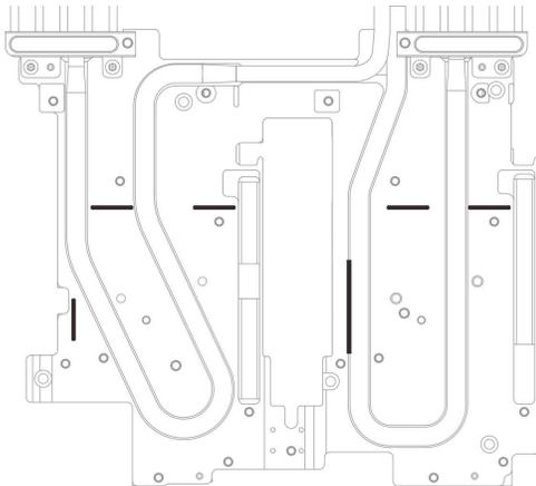
图 109. 水循环模块上的间隙垫对齐标记
