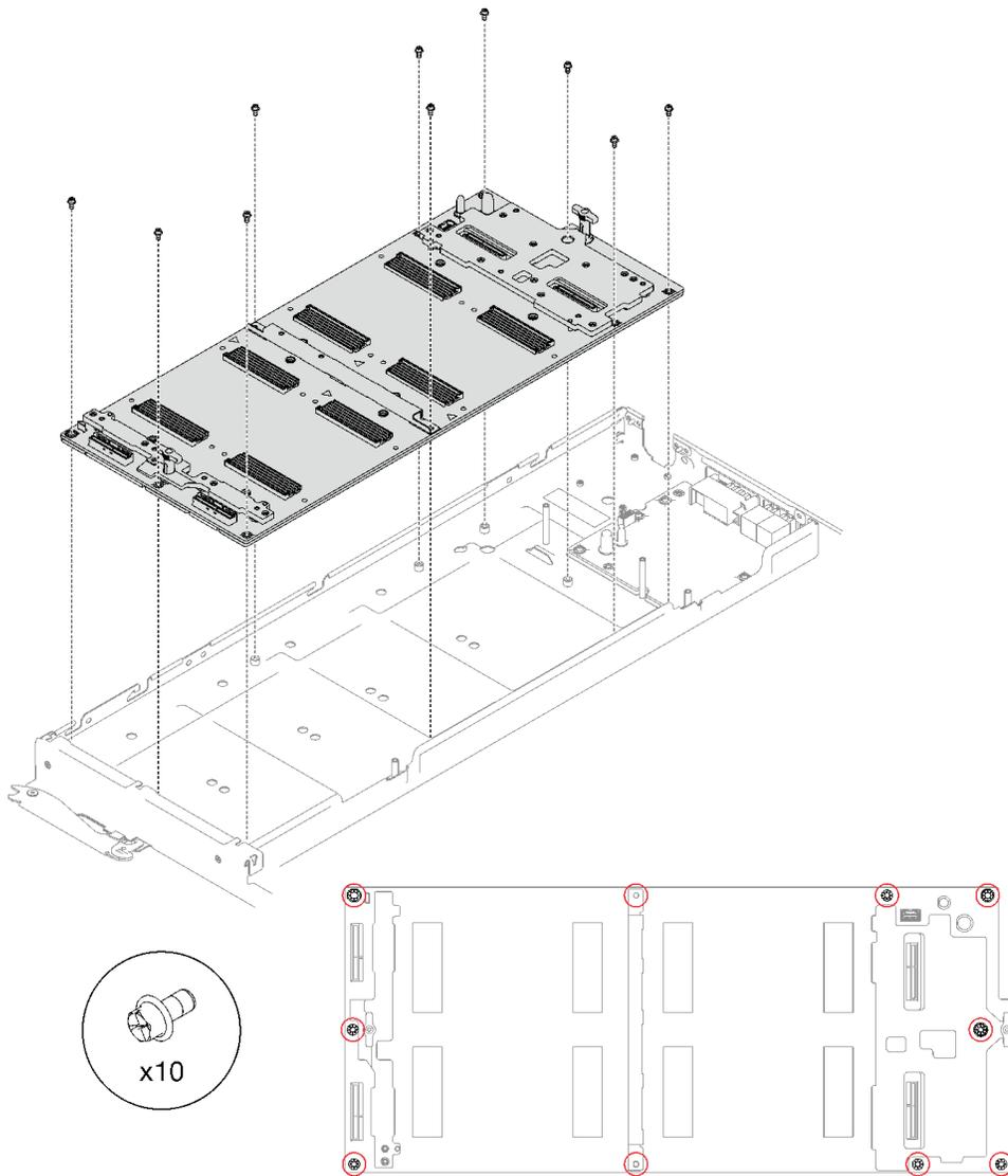
图 282. 安装承载基板
