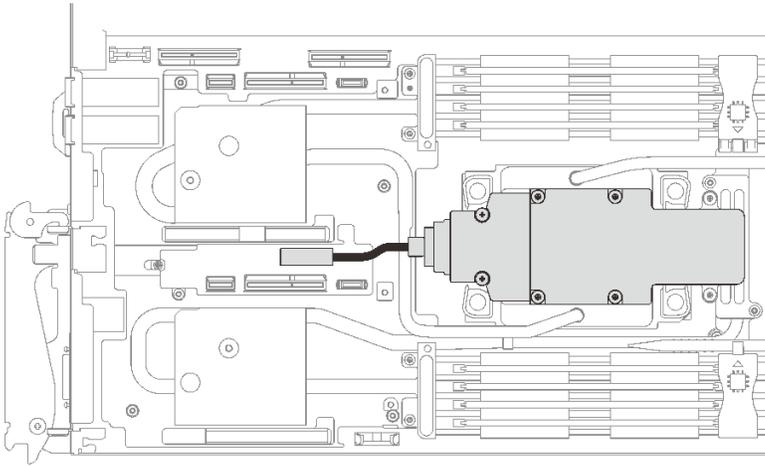
图 138. 拔下 M.2 背板组合件线缆
