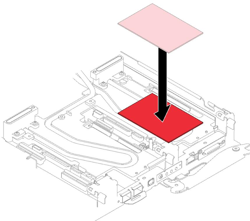
图 133. 更换间隙垫
