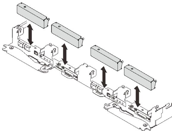
图 199. 卸下空挡板填充件
