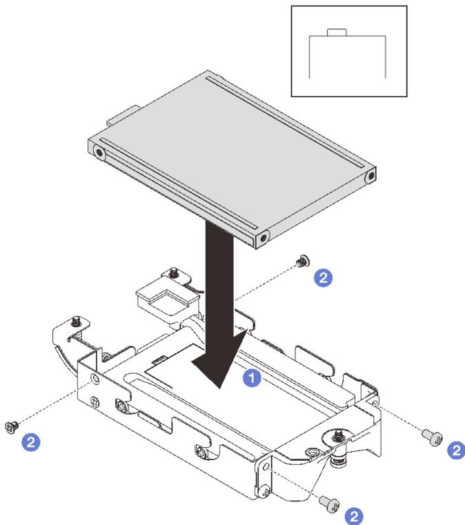
图 127. 安装底部 E3.s 硬盘
