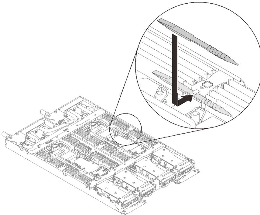
图 153. 安装内存条工具
