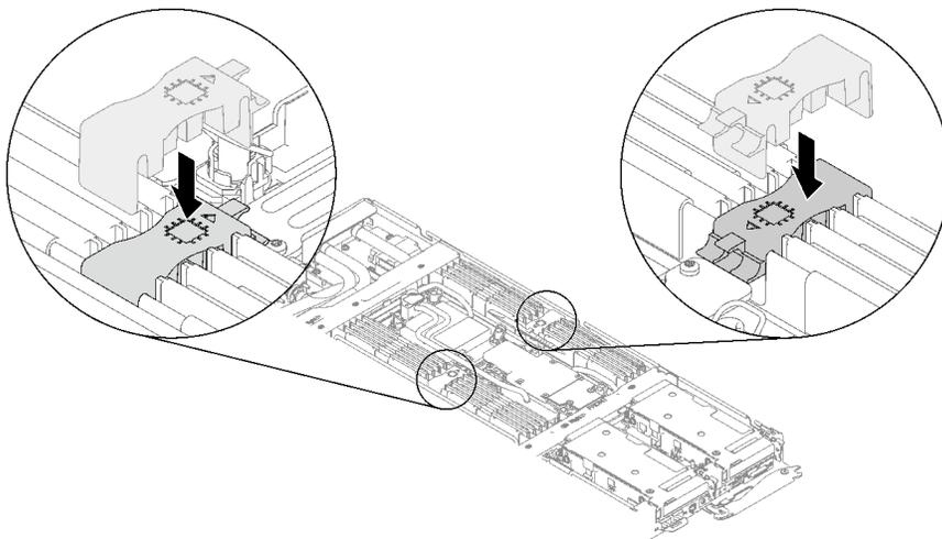
图 73. 安装 DIMM 梳
