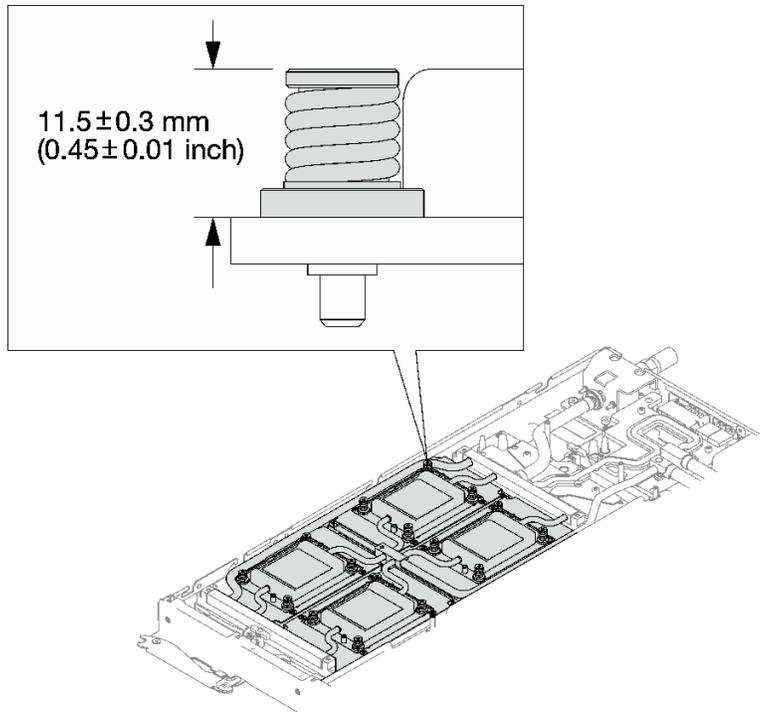
图 65. 正确安装的 GPU OAM 冷却板螺钉的高度
