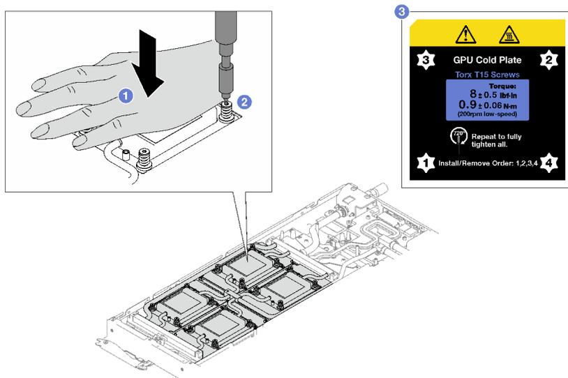
图 64. 将 GPU OAM 冷却板螺钉拧紧 720 度
