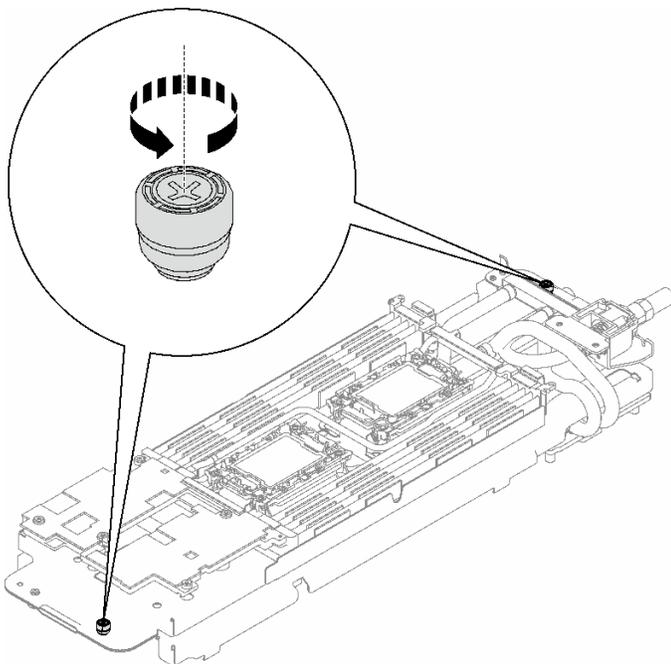
图 52. 拧松不脱指旋螺钉
