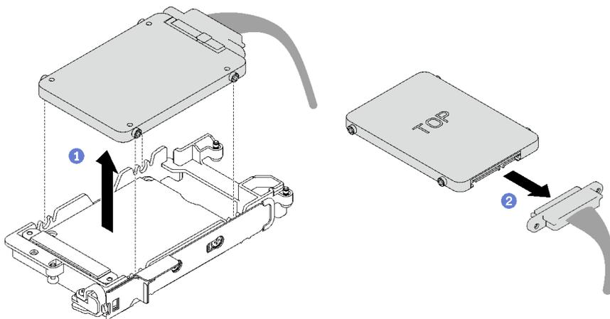
图 80. 卸下 7 毫米硬盘
