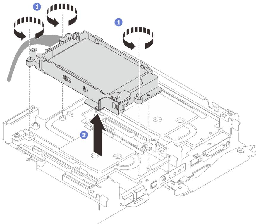
图 76. 卸下单 15 毫米硬盘仓组合件
