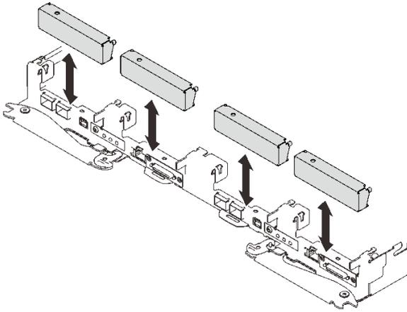
图 183. 安装空挡板填充件
