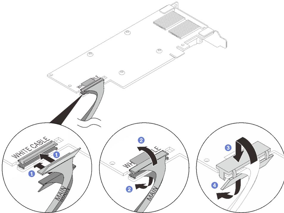
图 163. 安装 PCIe 适配器线缆
