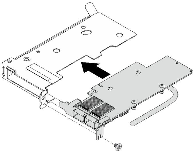
图 164. 安装 PCIe 适配器
