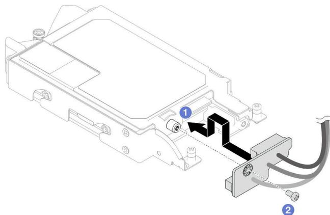
图 128. 安装 E3.s 线缆端背板
