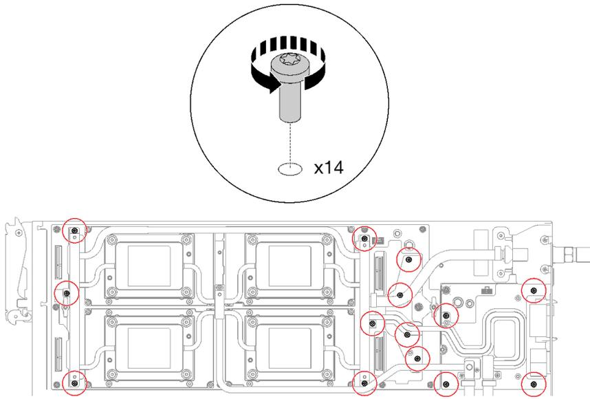
图 257. 卸下水循环模块螺钉
