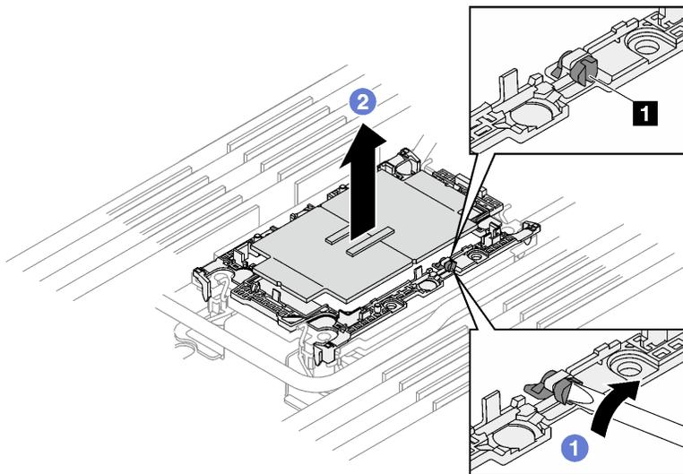
图 229. 卸下处理器 (Intel® Xeon® CPU Max 处理器)
