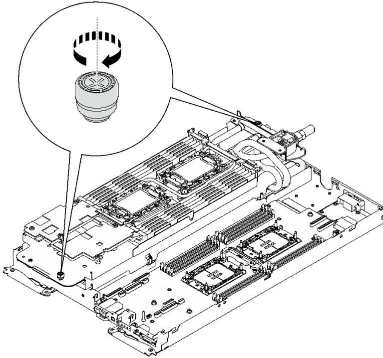
图 36. 拧紧松不脱指旋螺钉
