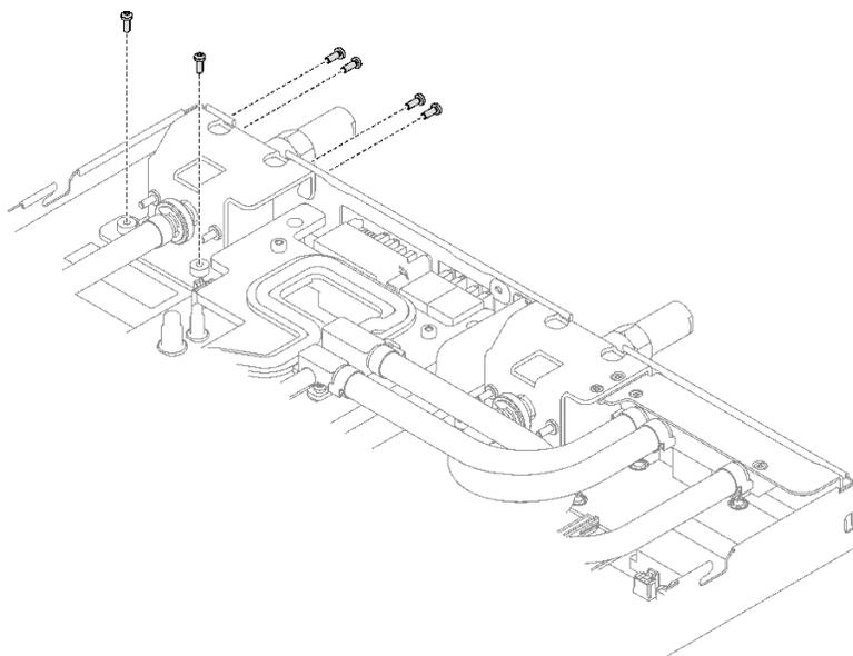
图 256. 卸下快接件螺钉
