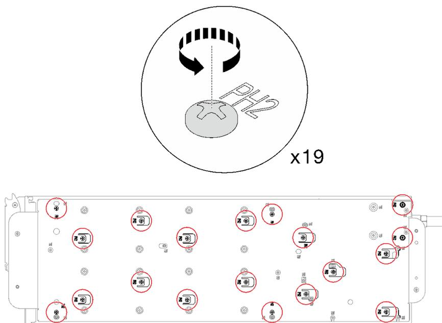
图 313. 拧松水循环模块载板的螺钉
