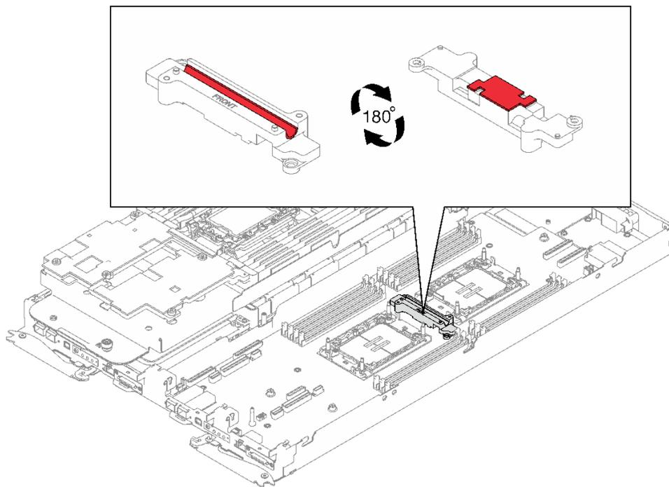
图 253. VR 水循环模块槽间隙垫
