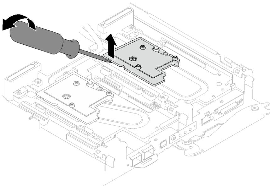
图 195. 将接口板从水循环模块冷却板上松开
