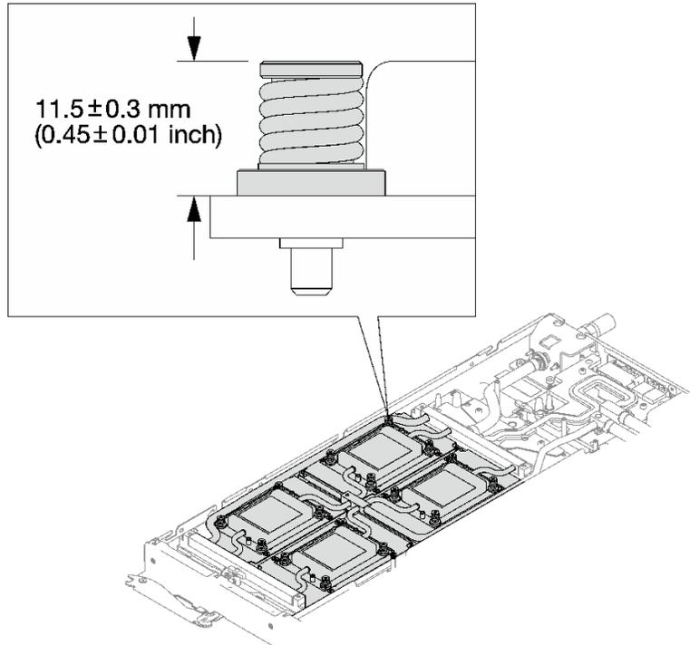
图 277. 正确安装的 GPU OAM 冷却板螺钉的高度
