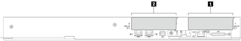
图 9. PCIe 插槽编号 - SD650-I V3 托盘
