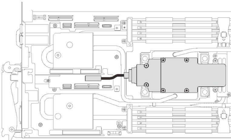
图 148. 安装 M.2 背板组合件线缆
