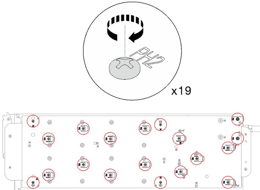
图 302. 安装水循环模块载板的螺钉
