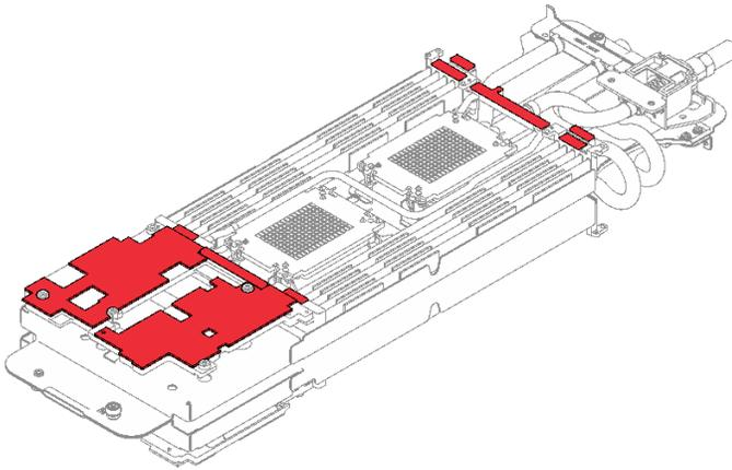
图 212. 水循环模块间隙垫
