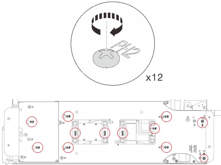
图 207. 安装水循环模块载板的螺钉
