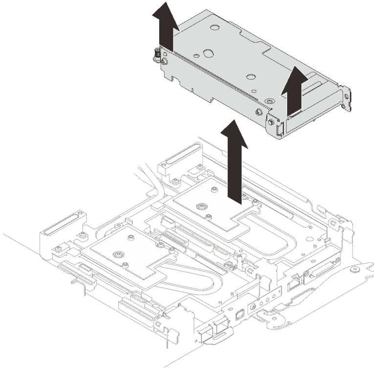
图 192. 卸下 PCIe 转接卡架组合件
