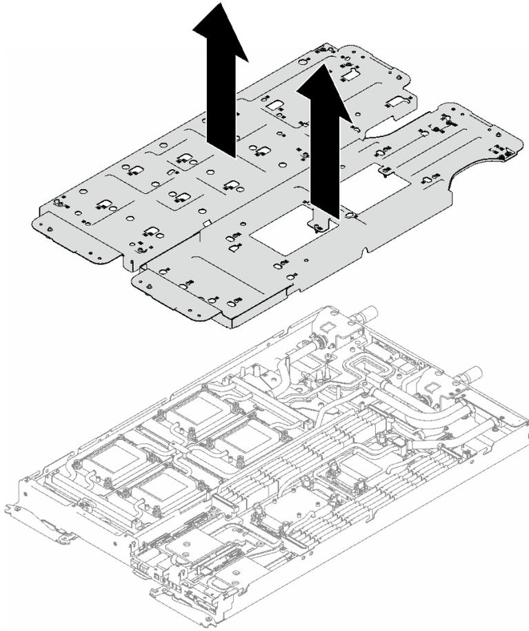
图 60. 卸下水循环模块载板
