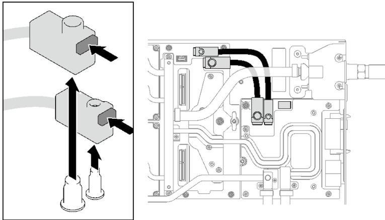
图 320. 电源线接头
