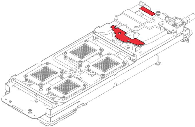
图 310. 水循环模块间隙垫
