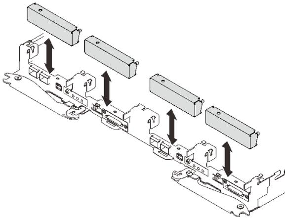
图 79. 安装空挡板填充件
