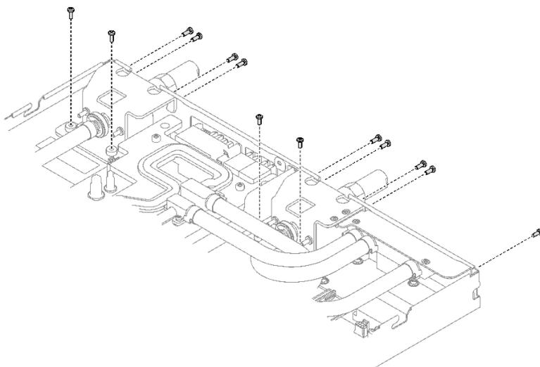
图 62. 安装快接件螺钉
