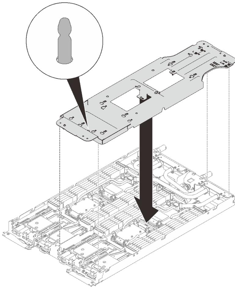
图 206. 安装水循环模块载板
