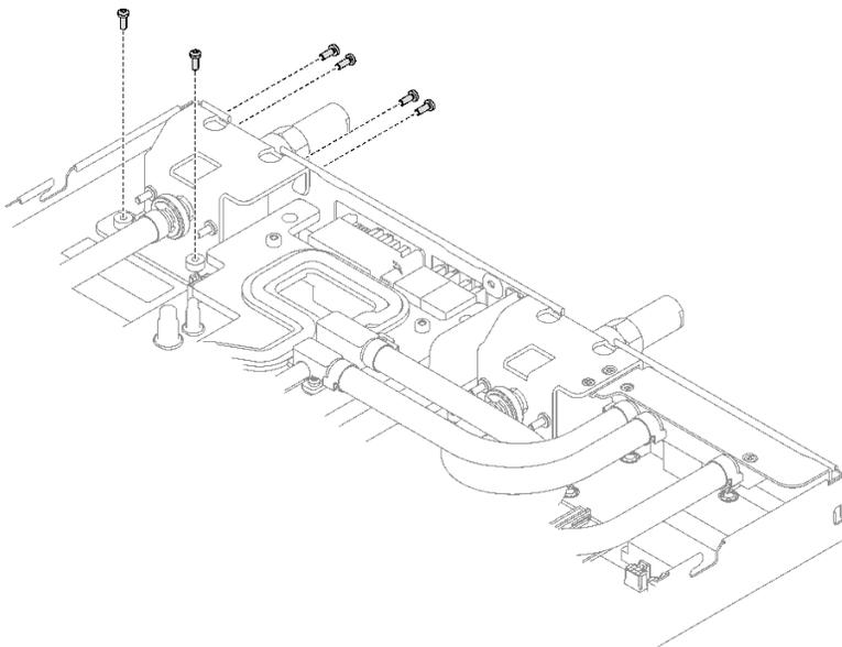
图 296. 卸下快接件螺钉
