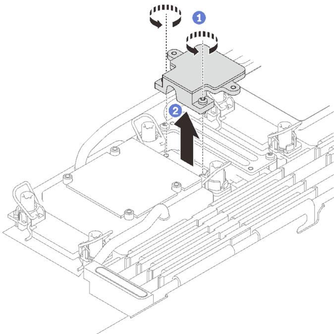
图 140. 卸下 M.2 背板冷却板
