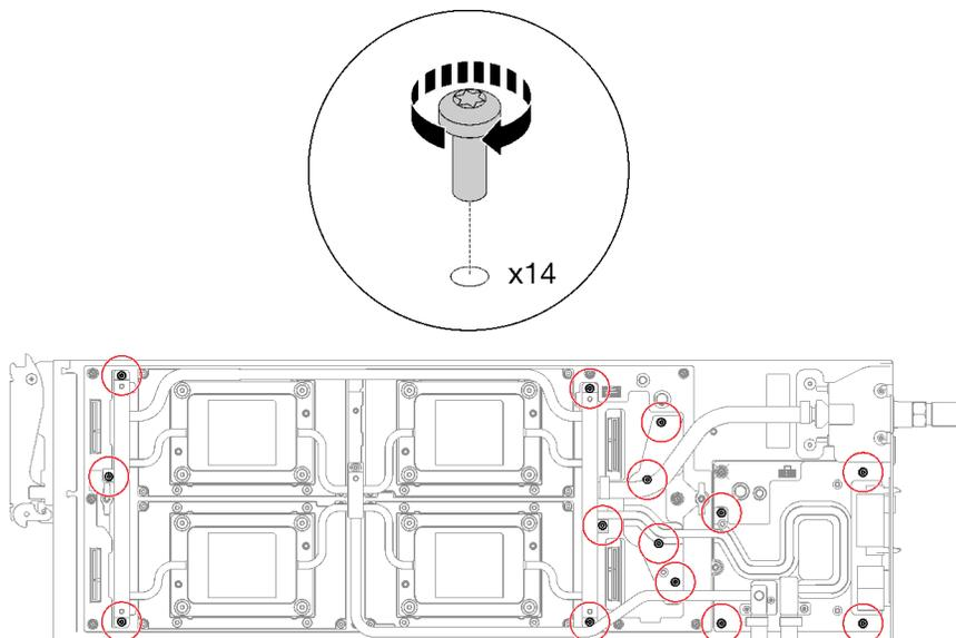
图 273. 安装水循环模块螺钉
