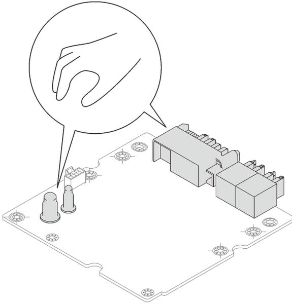
图 306. SD650-I V3 GPU 配电板操作点
