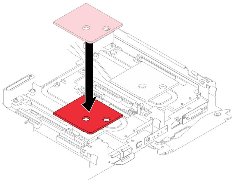
图 93. 更换间隙垫
