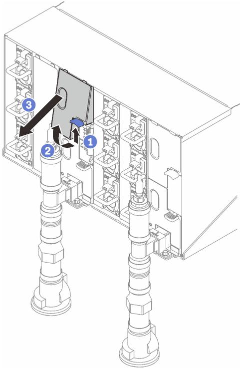
图 334. 卸下上方 EMC 保护罩
