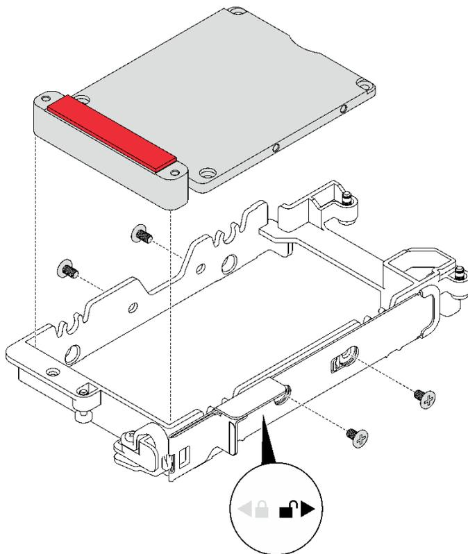
图 84. 卸下导电板
