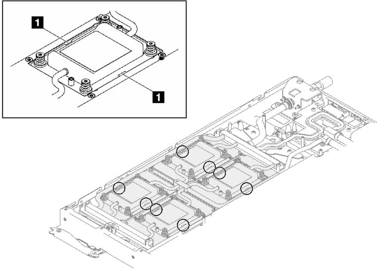
图 259. GPU OAM 冷却板上的槽口
