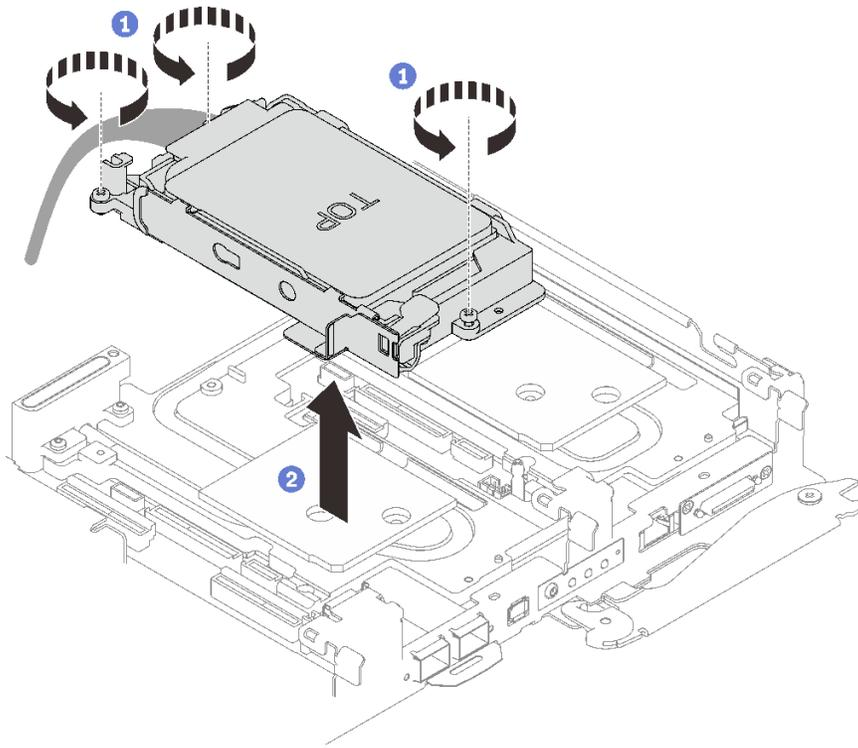
图 78. 卸下双 7 毫米硬盘仓组合件
