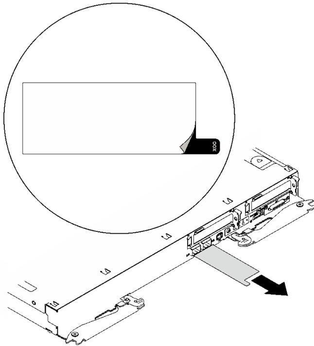
图 14. 抽取式信息卡上的 Lenovo XClarity Controller 网络访问标签
