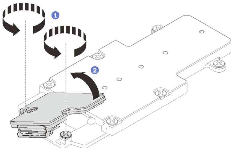
图 141. 拆卸 M.2 背板组合件
