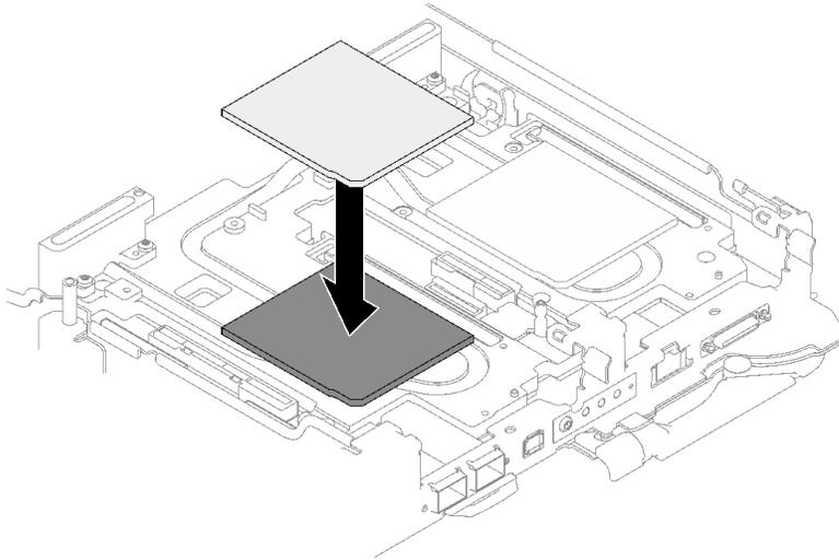
图 110. 更换间隙垫
