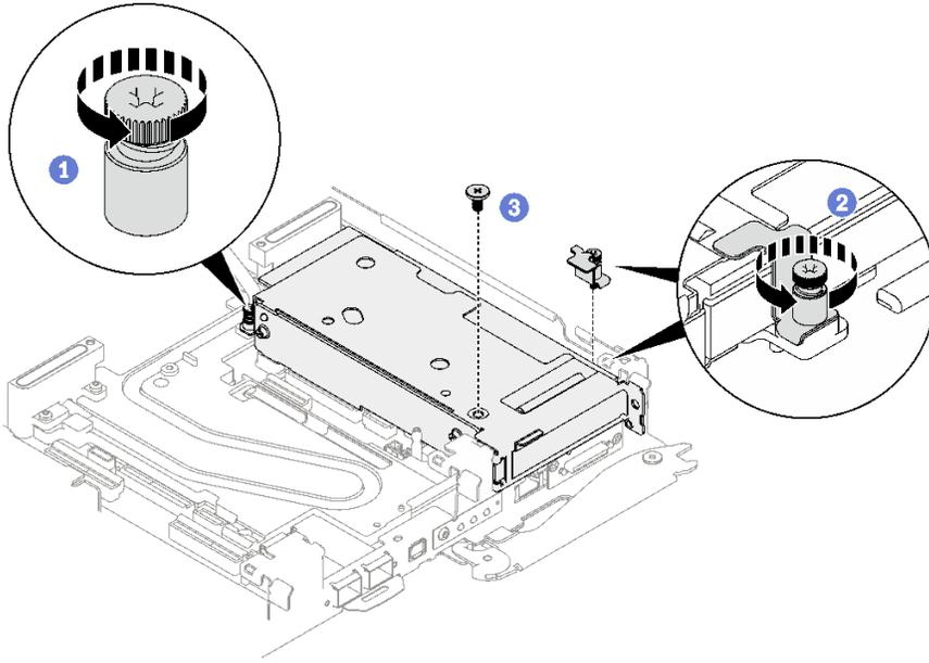
图 166. 卸下夹持支架的松不脱螺钉
