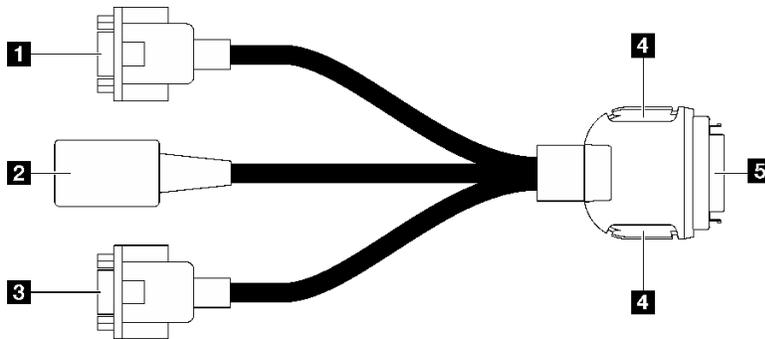
图 5. KVM 分支线缆上的接口和组件
