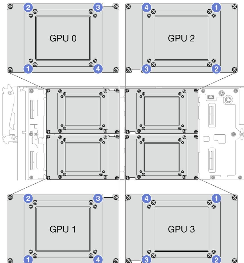
图 266. 安装 GPU OAM 时的螺钉拧紧顺序
