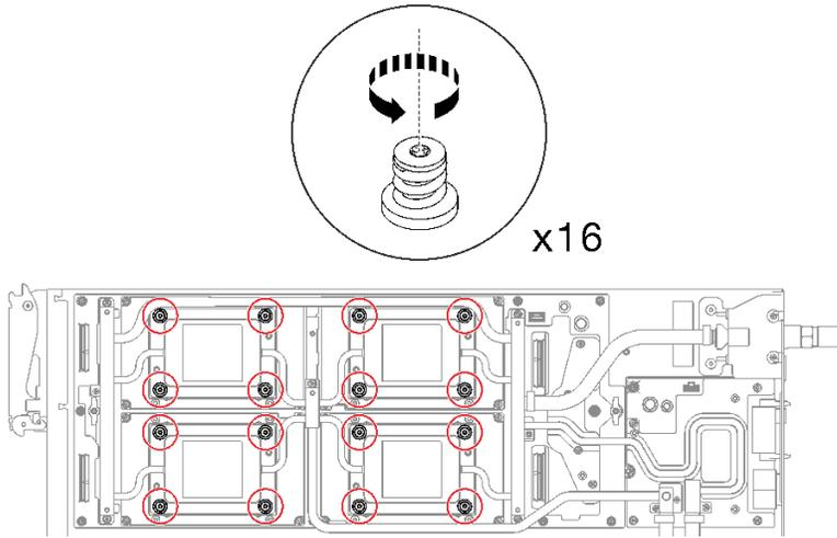
图 298. 卸下 GPU OAM 冷却板螺钉
