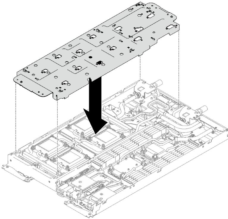
图 261. 安装水循环模块载板
