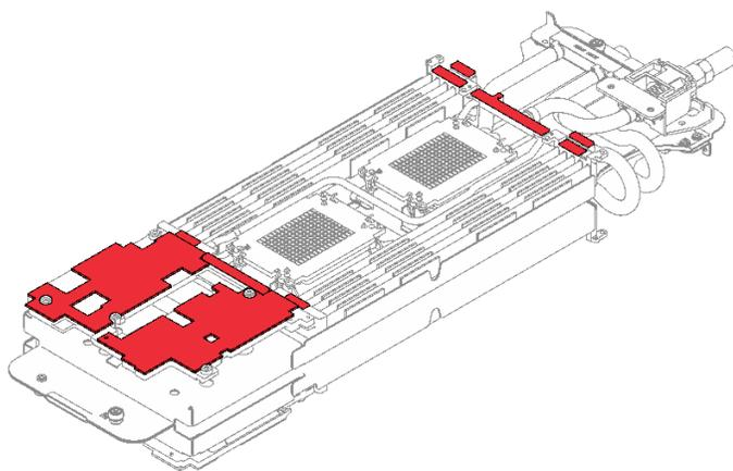
图 49. 水循环模块间隙垫
