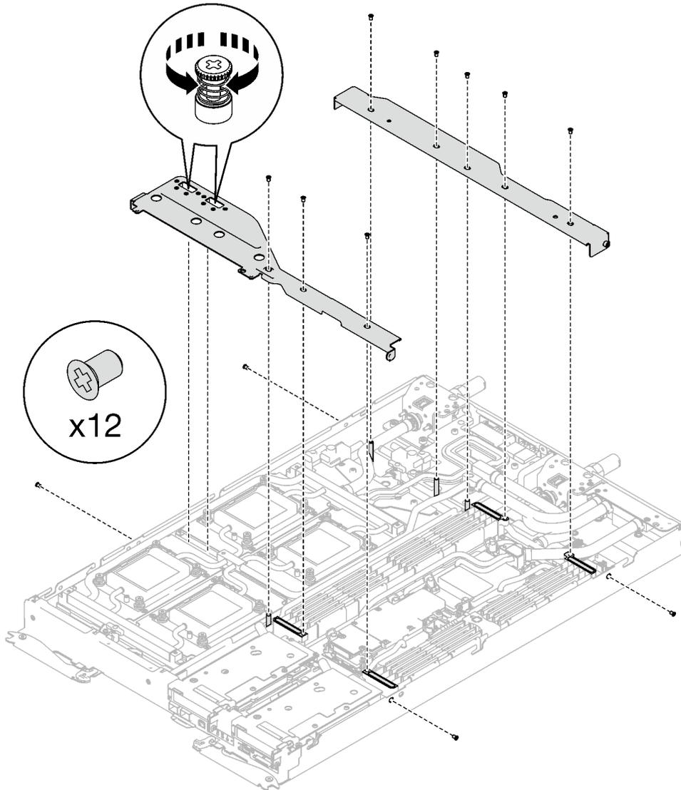
图 24. 安装横梁 (SD650-I V3)
