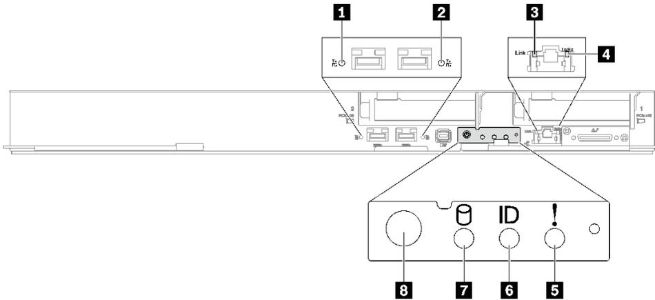
图 326. SD650-I V3 托盘正面 LED
