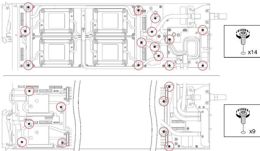
图 28. 卸下水循环模块螺钉
