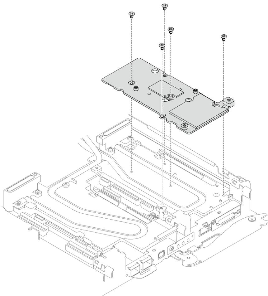
图 186. 安装接口板
