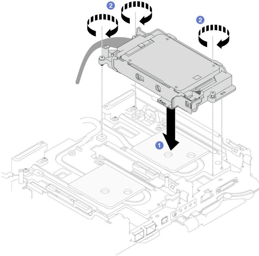
图 112. 安装 7 毫米 NVMe 硬盘仓组合件
