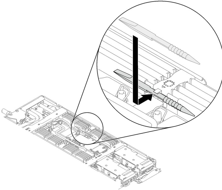
图 158. 安装内存条工具
