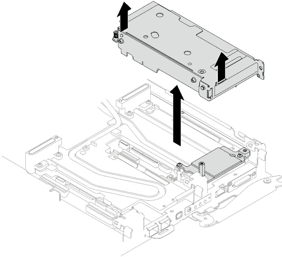
图 167. 卸下 PCIe 转接卡组合件
