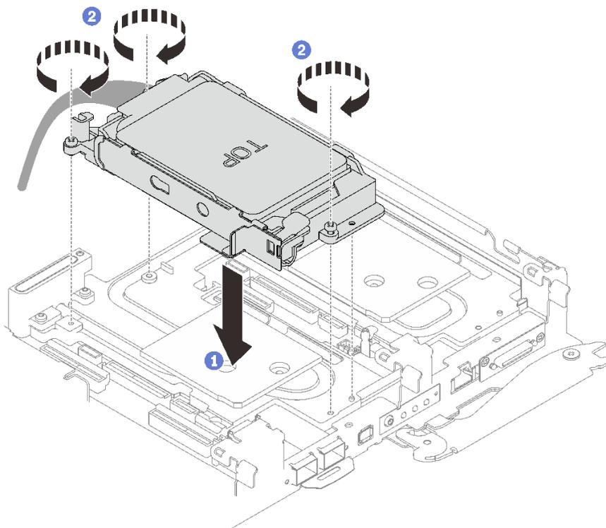
图 97. 安装双 7 毫米硬盘仓组合件
