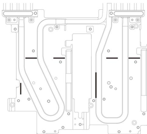
图 92. 水循环模块上的间隙垫对齐标记
