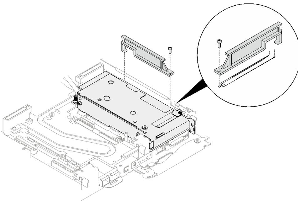
图 176. 安装导热管架
