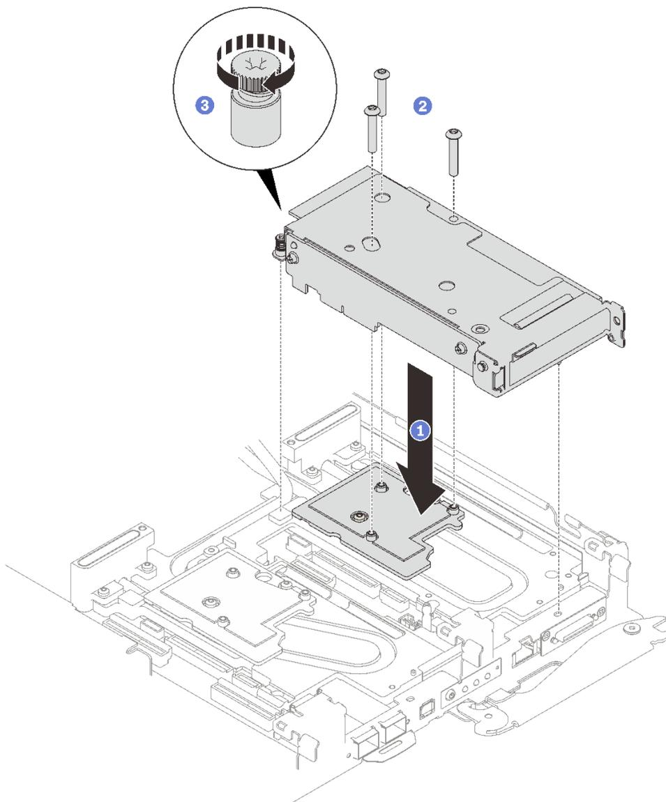
图 202. 安装 PCIe 转接卡组合件
