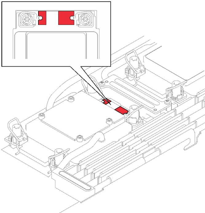
图 145. 处理器冷却板上的间隙垫
