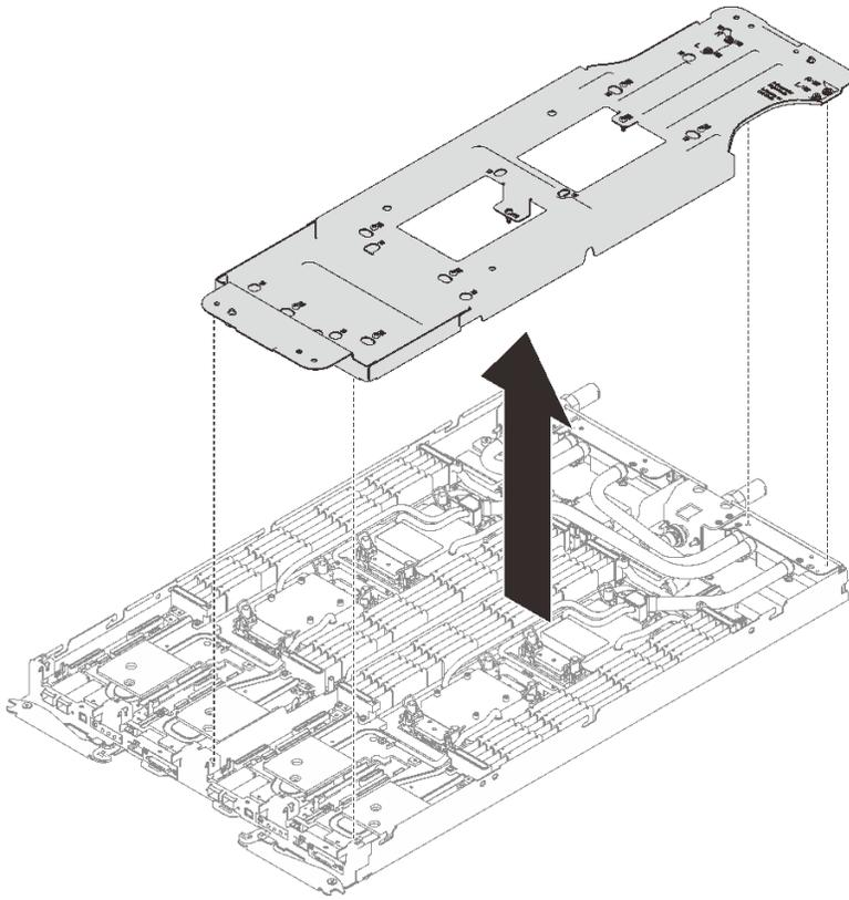
图 216. 卸下水循环模块载板
