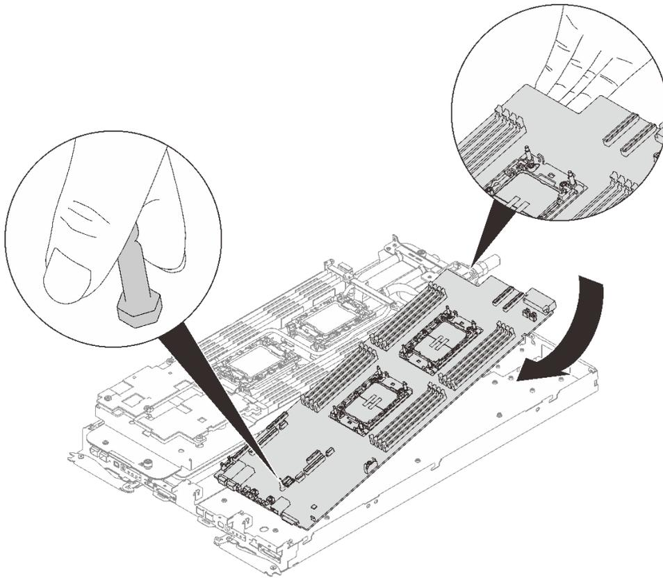
图 251. 安装主板
