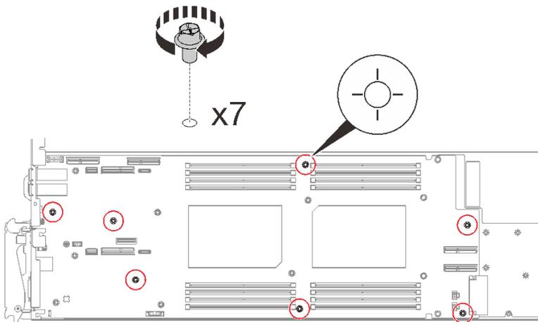
图 252. 安装主板螺钉
