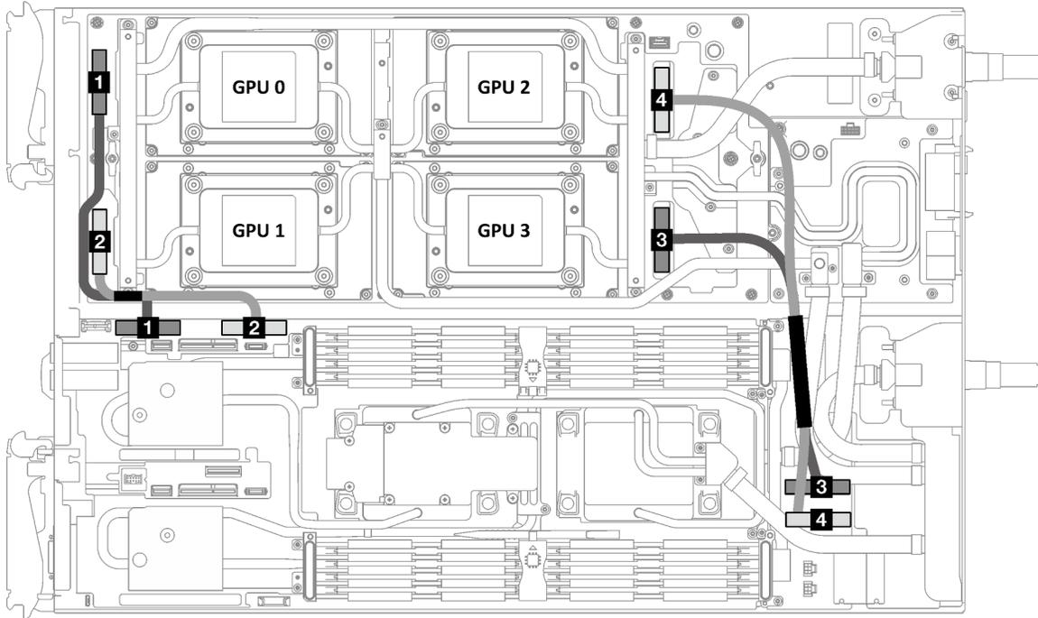
图 322. SD650-I V3 托盘信号线缆布放
