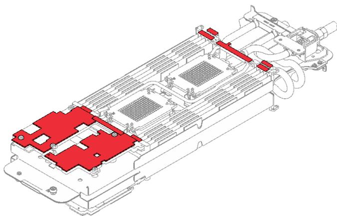
图 239. 水循环模块间隙垫
