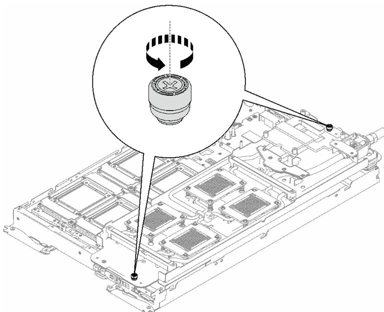
图 56. 拧松松不脱指旋螺钉
