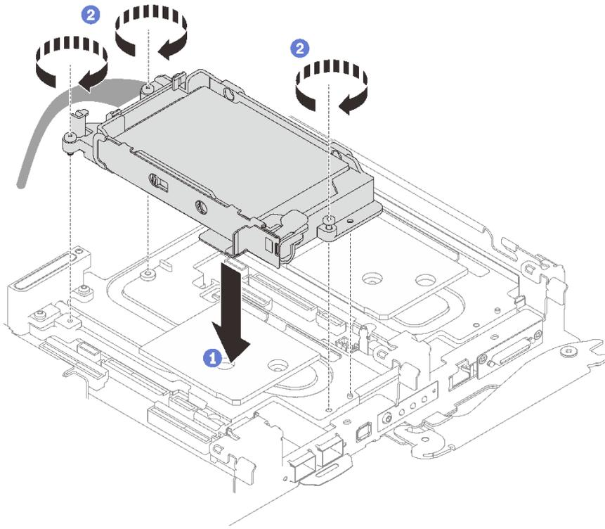
图 95. 安装单 15 毫米硬盘仓组合件
