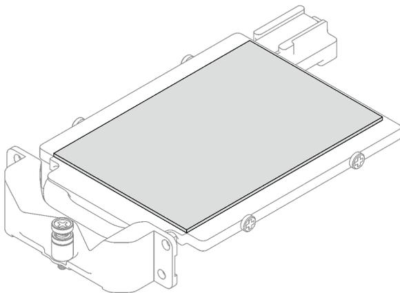
图 124. 更换导电板间隙垫
