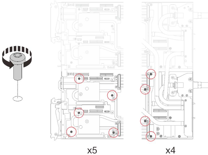
图 222. 卸下水循环模块螺钉
