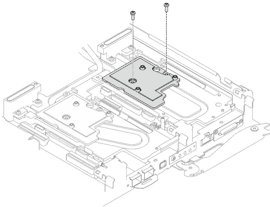
图 200. 安装接口板
