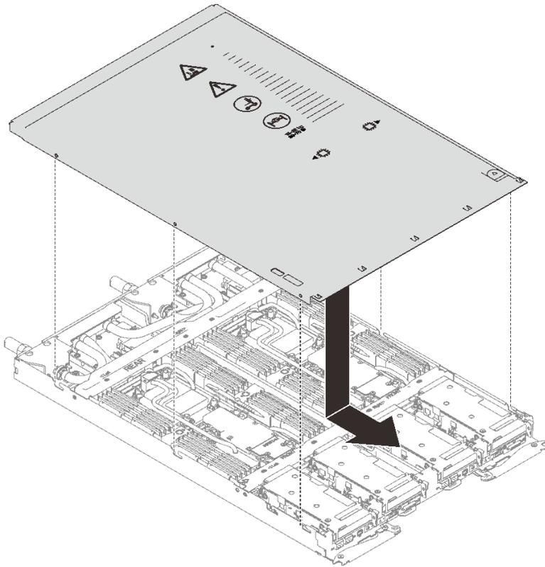
图 21. 安装托盘外盖
