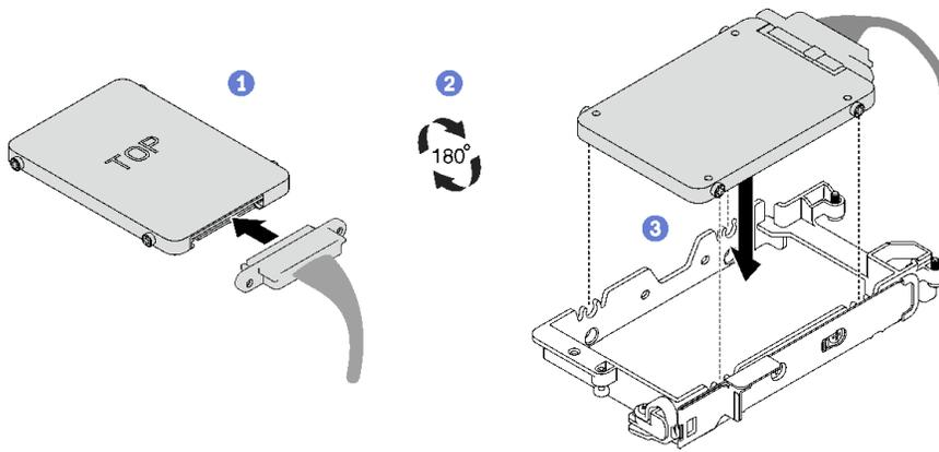
图 85. 安装 7 毫米硬盘
