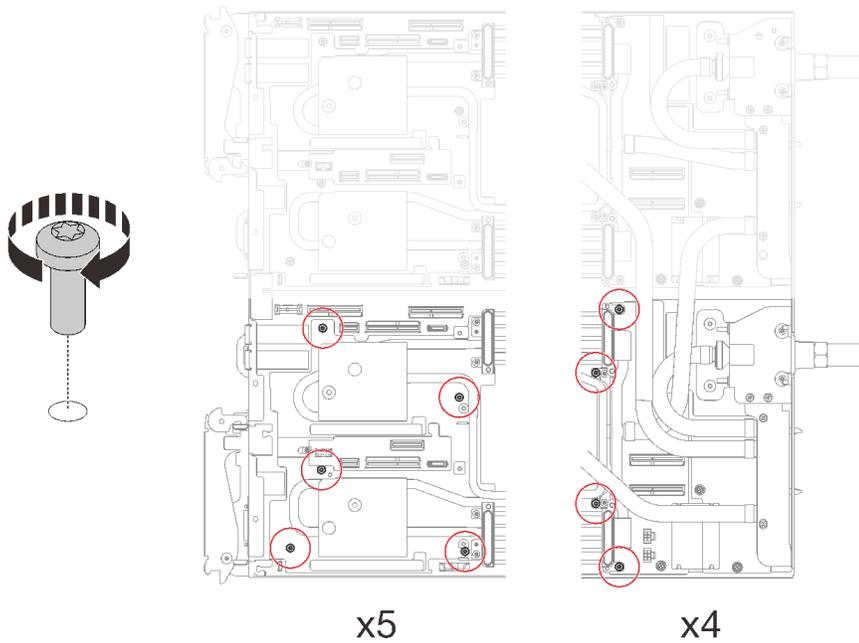
图 244. 安装水循环模块螺钉
