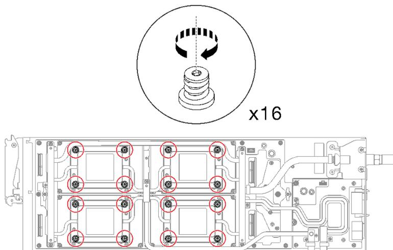
图 63. 安装 GPU OAM 冷却板螺钉
