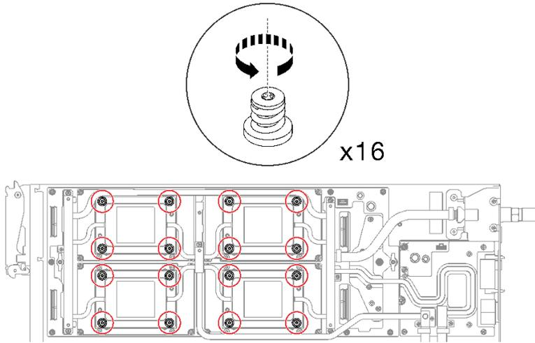
图 29. 卸下 GPU OAM 冷却板螺钉
