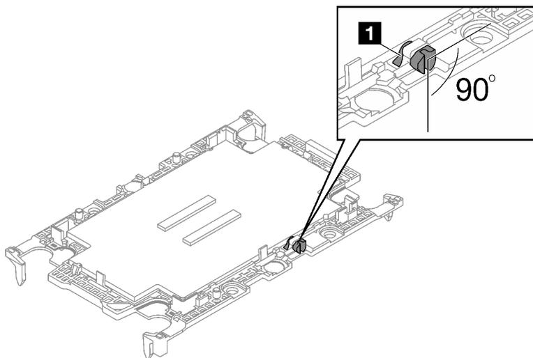
图 235. 处理器固定器上的 TIM 断开凸轮
