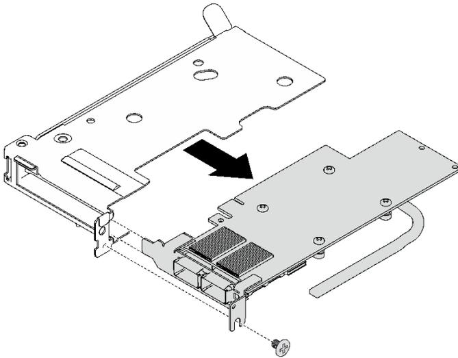
图 159. 卸下 PCIe 适配器
