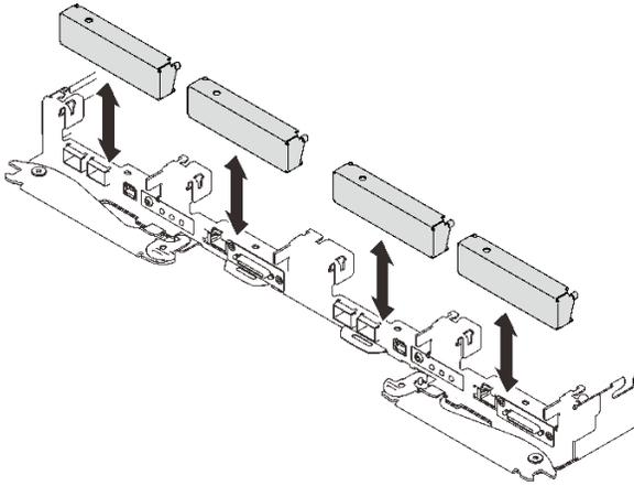
图 185. 卸下空挡板填充件
