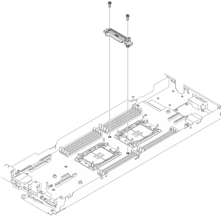
图 247. 卸下 VR 水循环模块槽
