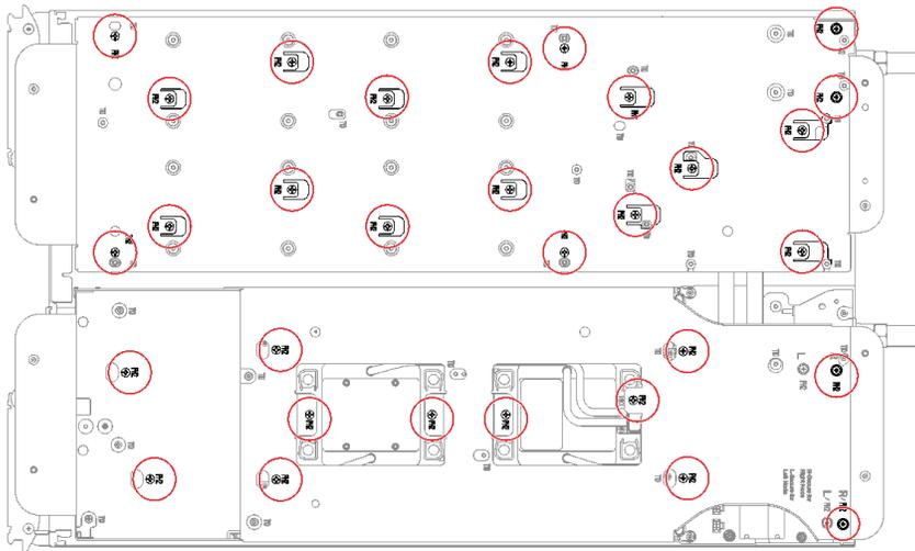
图 34. 安装水循环模块载板的螺钉
