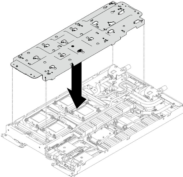
图 301. 安装水循环模块载板
