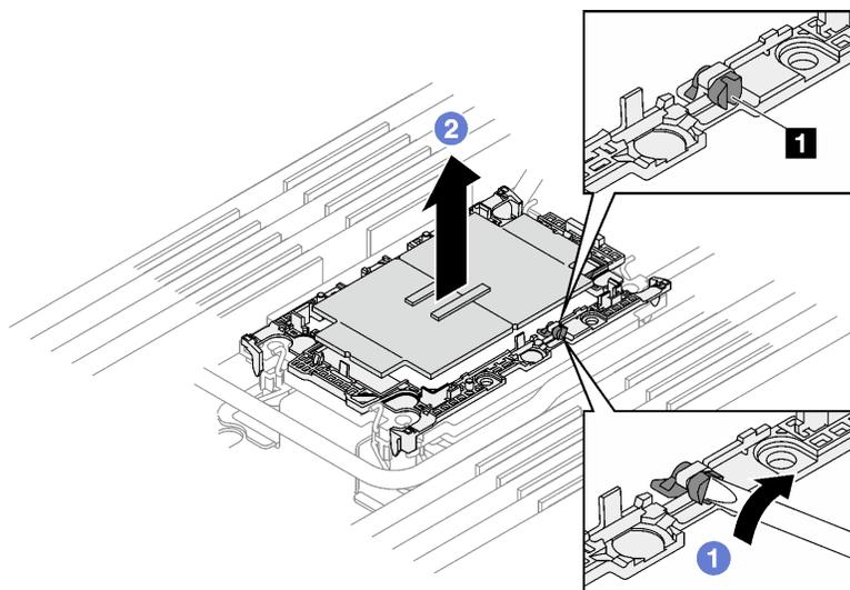
图 38. 卸下处理器 (Intel® Xeon® CPU Max 处理器)
