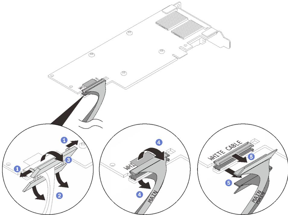
图 160. 拔下 PCIe 适配器线缆
