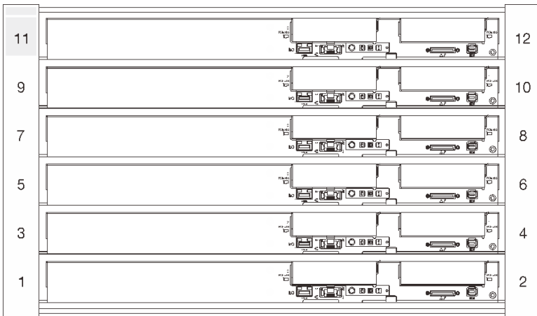
图 8. 带有六个 SD650-N V2 托盘的机柜
