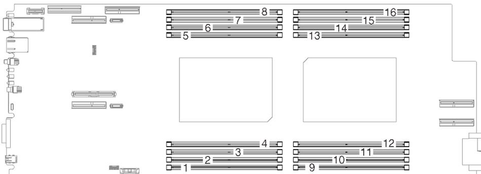
图 33. 主板上 DIMM 接口的位置
