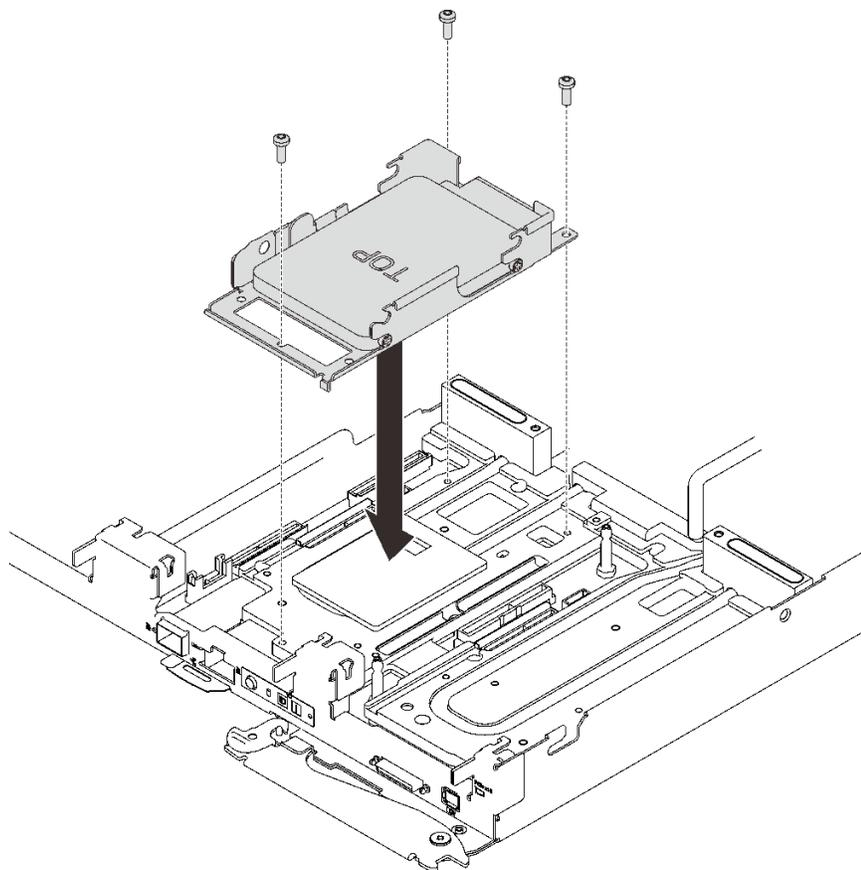
图 58. 安装单硬盘仓组合件
