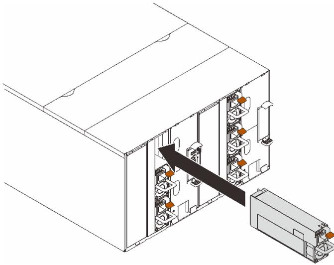
图 77. 安装热插拔电源模块
