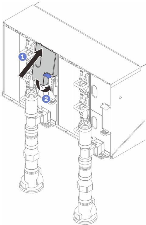
图 75. 安装 EMC 保护罩
