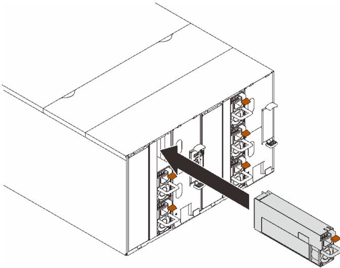
图 69. 安装电源模块
