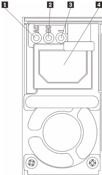
图 14. 电源模块 LED 和接口
