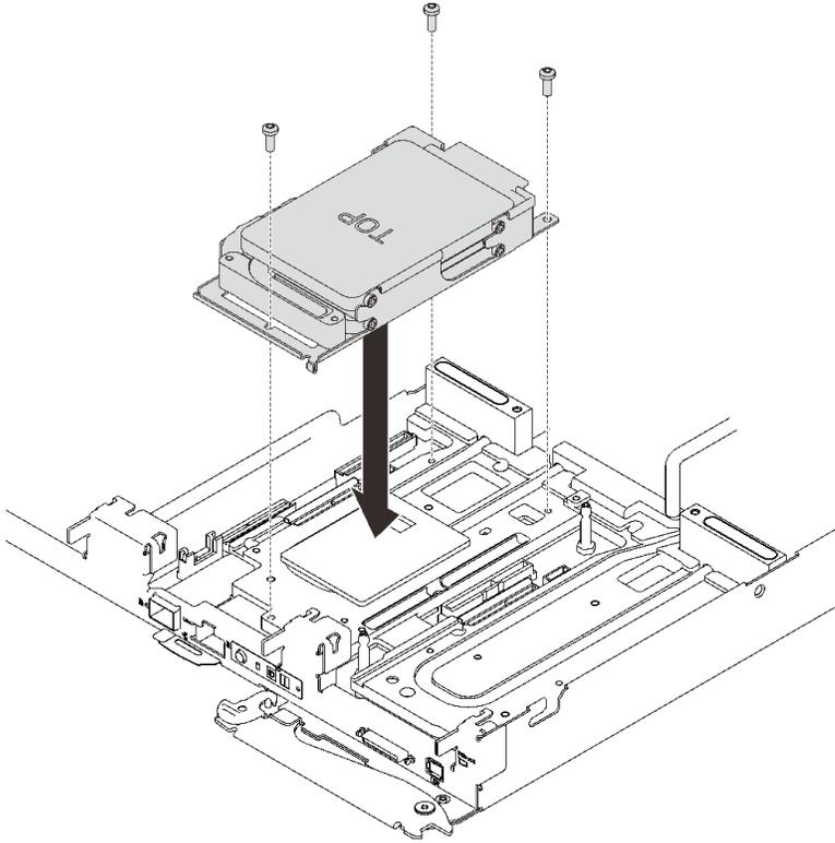
图 59. 安装双硬盘仓组合件
