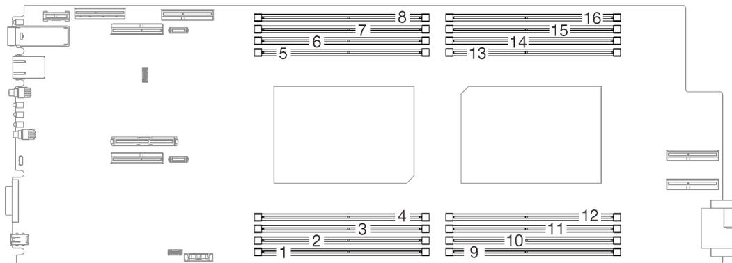
图 16. 计算节点主板上 DIMM 接口的位置
