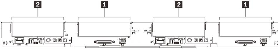
图 19. PCIe 插槽编号 - SD650 V2 托盘
