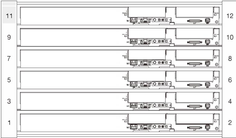
图 8. 带有六个 SD650-N V2 托盘的机柜
