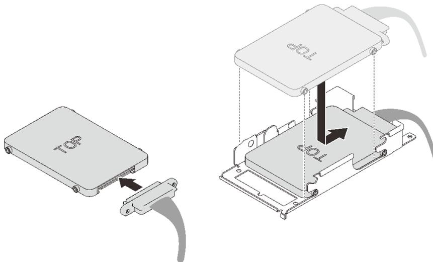
图 50. 安装下方硬盘
