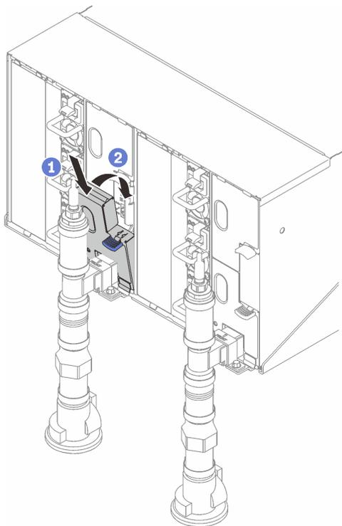
图 76. 安装 EMC 保护罩
