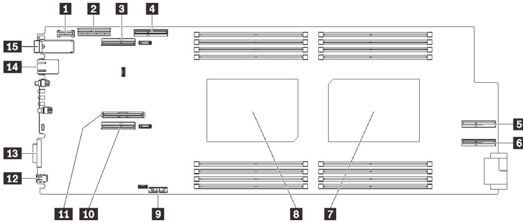
图 15. 计算节点主板上的内部接口
