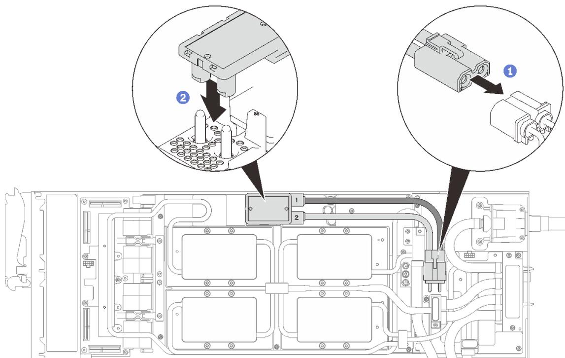
图 24. 安装 GPU 电源线
