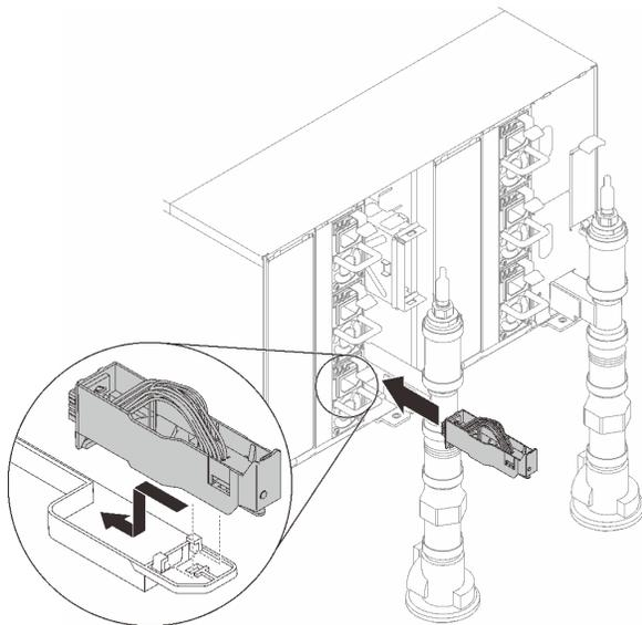
图 74. 安装液滴传感器组合件
