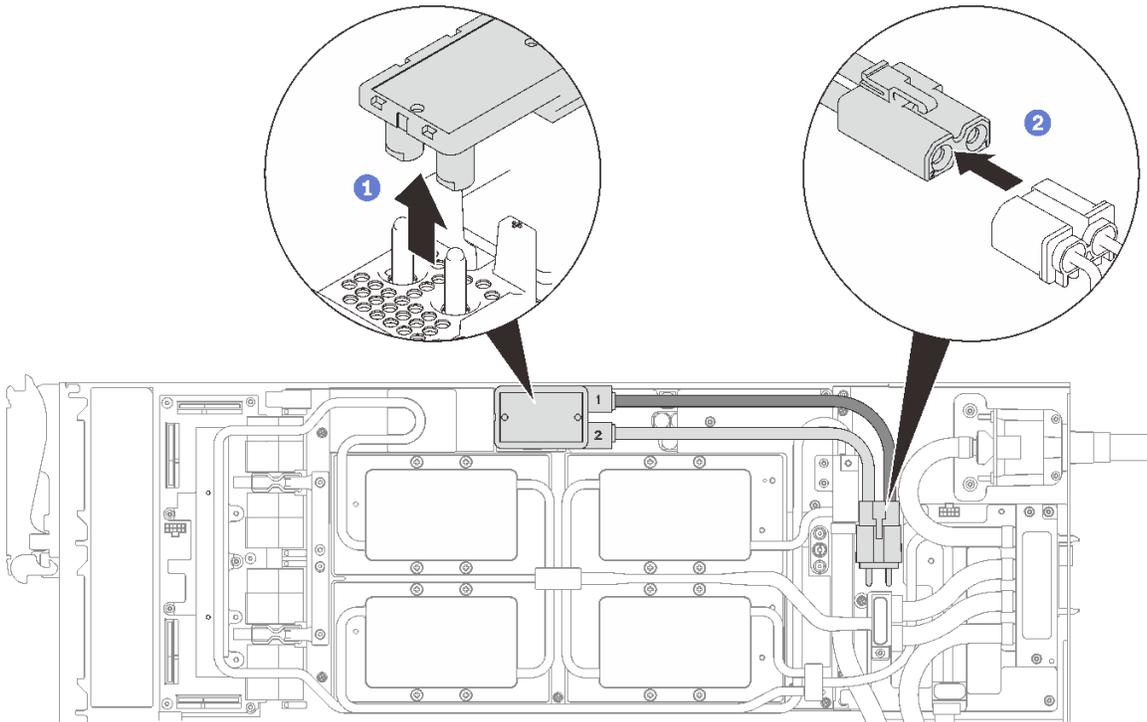
图 29. 拔下 GPU 电源线
