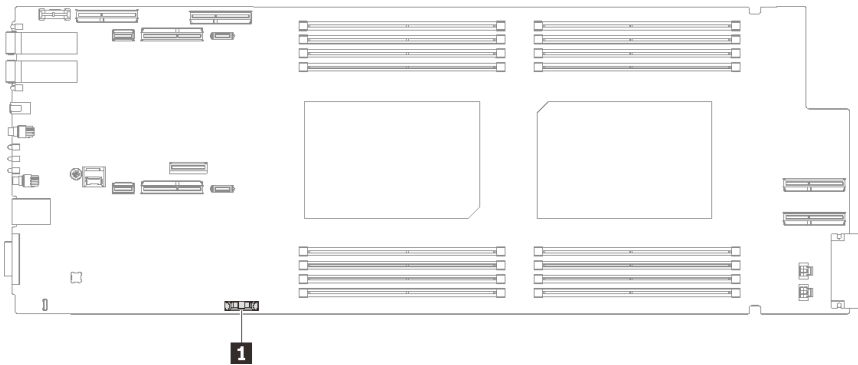
图 54. CMOS 电池位置
