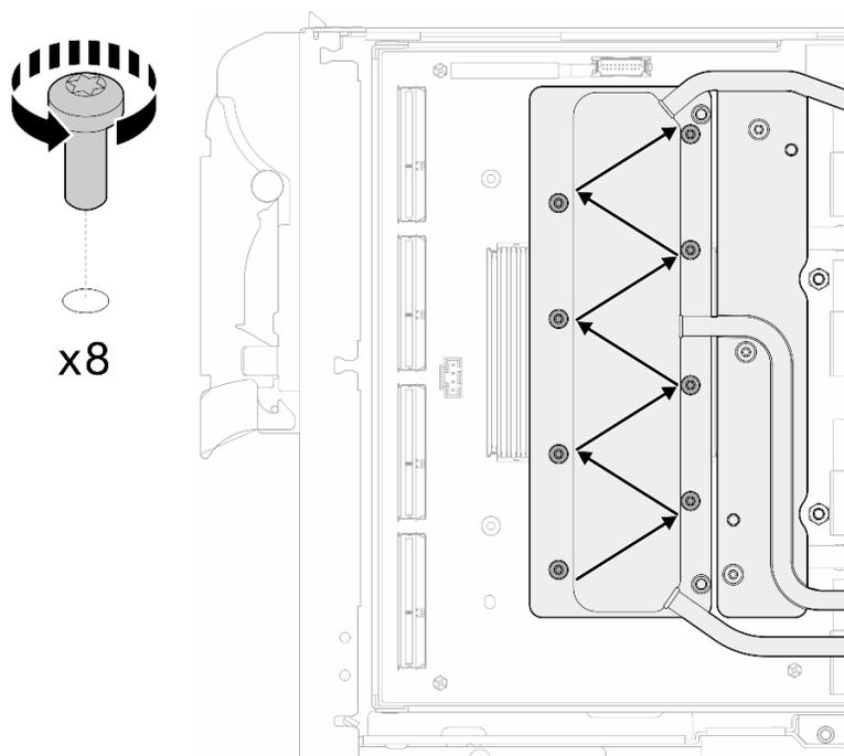
図16. ネットワーク・カードのねじの取り外し
