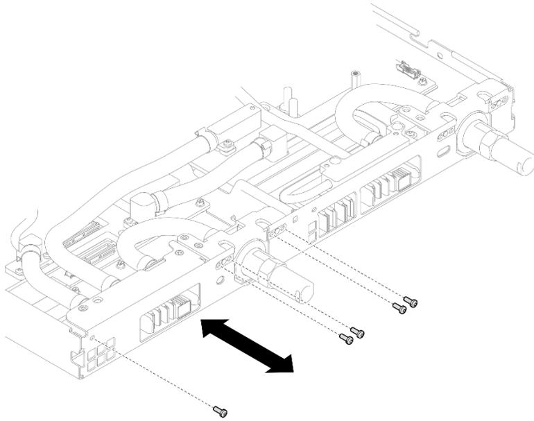
図56. クイック・コネクットのねじの取り付け (計算ノード)
