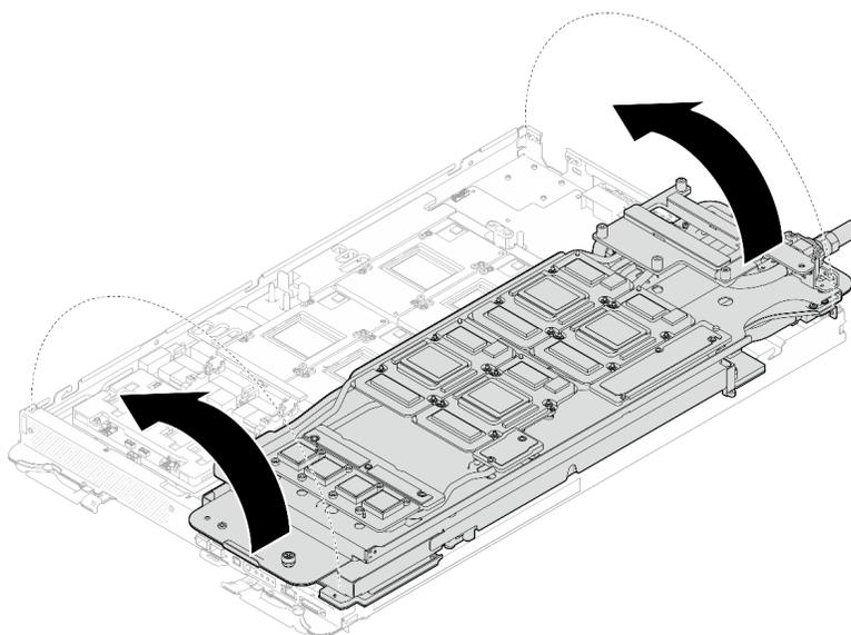
図343. GPU ノードにウォーター・ループを広げる
