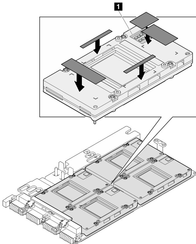
図 436. GPU パテ・パッドの交換
