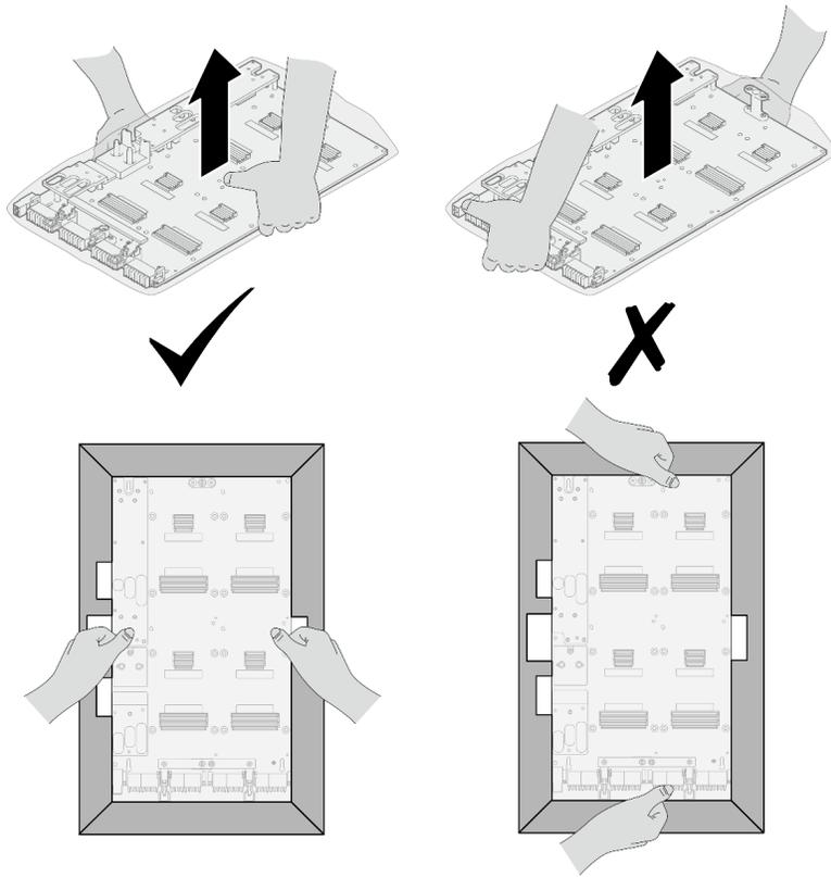
図 359. パッケージ・ボックスからの GPU ボードの取り出し
