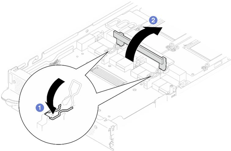
図 365. GPU ボードへのキャリア・ボードの固定
