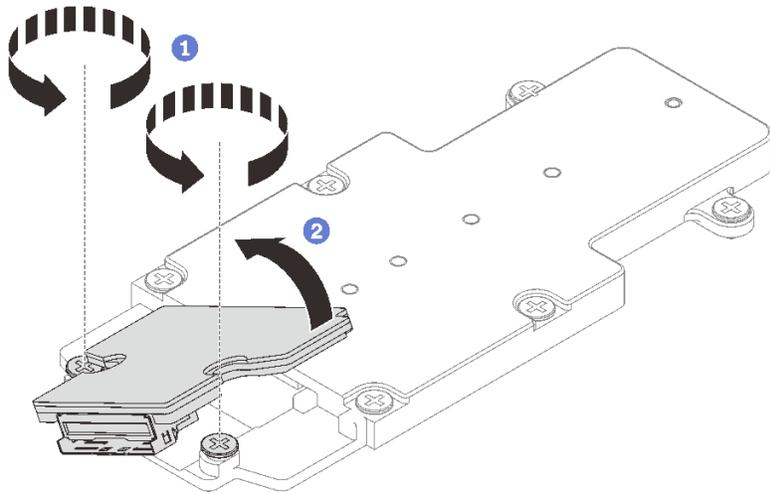
図144. M.2 バックプレーン・アセンブリーの分解
