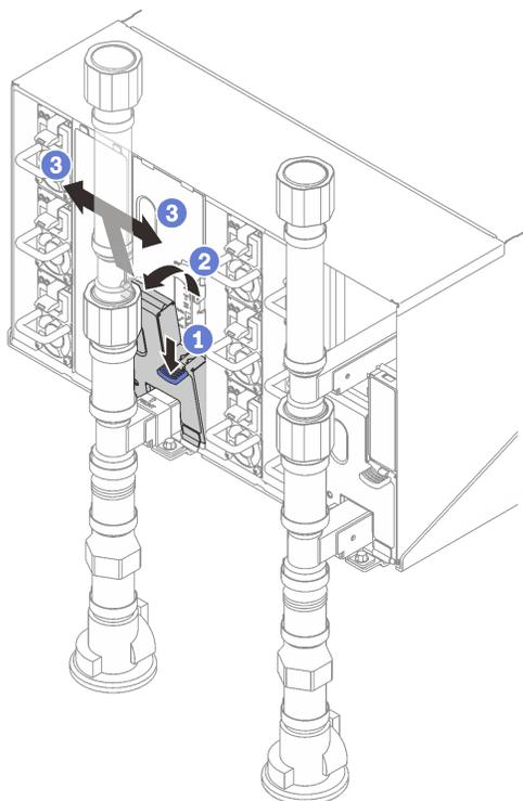
図 465. 下段の EMC シールドの取り外し
