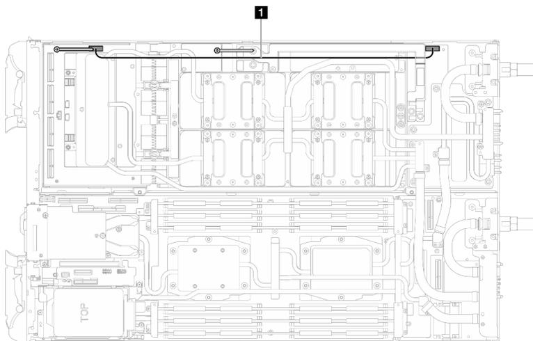
図 321. キャリア・ボードの電源ケーブルの取り外し
