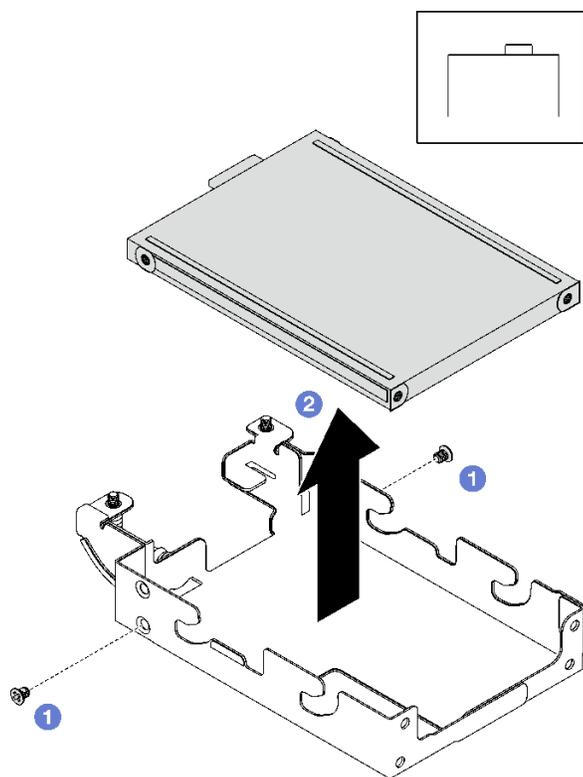
図 129. 上部 E3.s ドライブの取り外し
