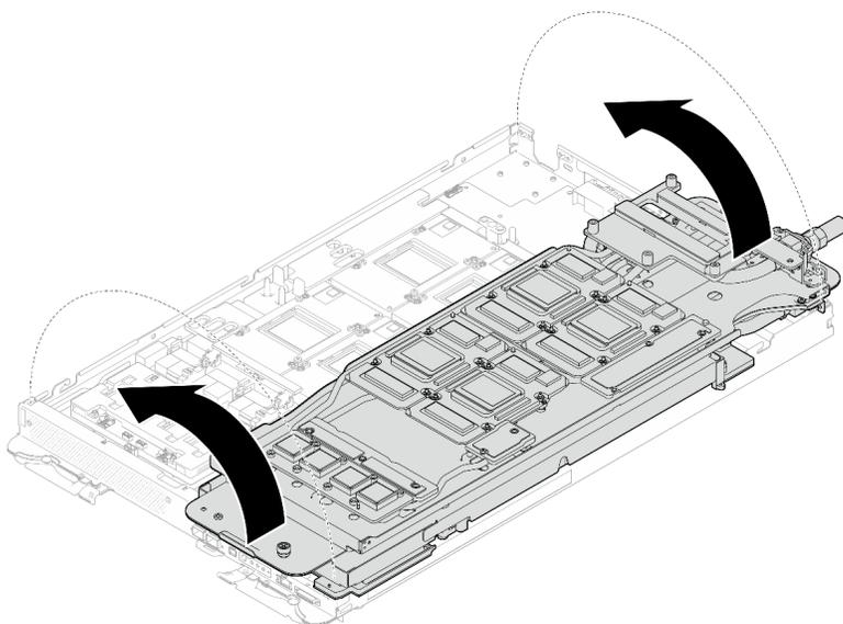
図 437. GPU ノードにウォーター・ループを広げる
