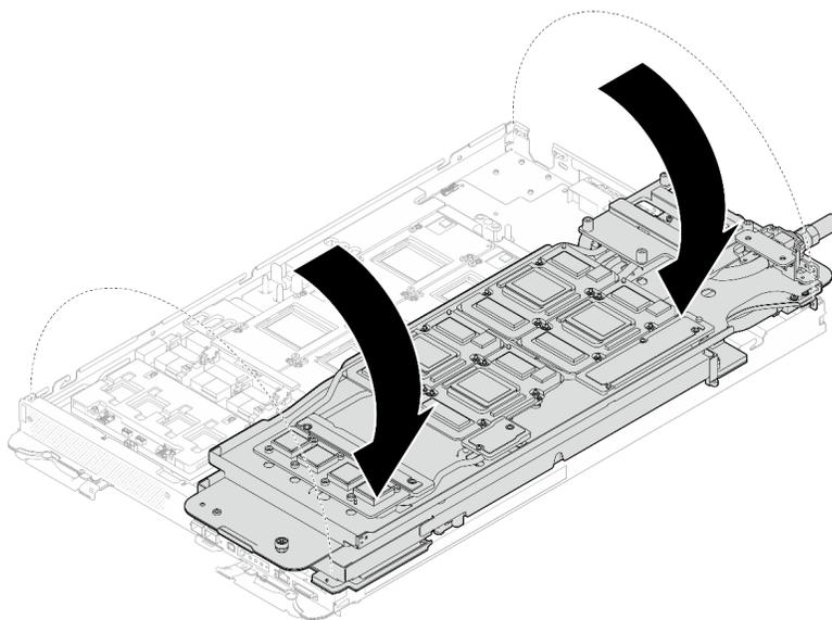
図23. GPU ノード側のウォーター・ループを計算ノード側のウォーター・ループに折りたたむ
