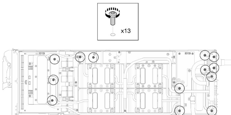
図 14. ウォーター・ループの Torx T10 ねじの取り外し (GPU ノード)
