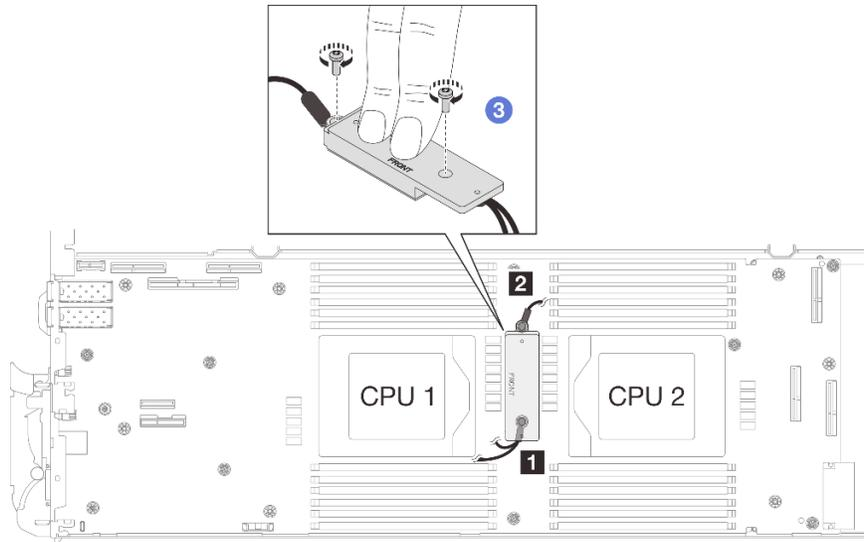
図 75. 遮蔽ケーブル 1/2 および 3 の取り付け
