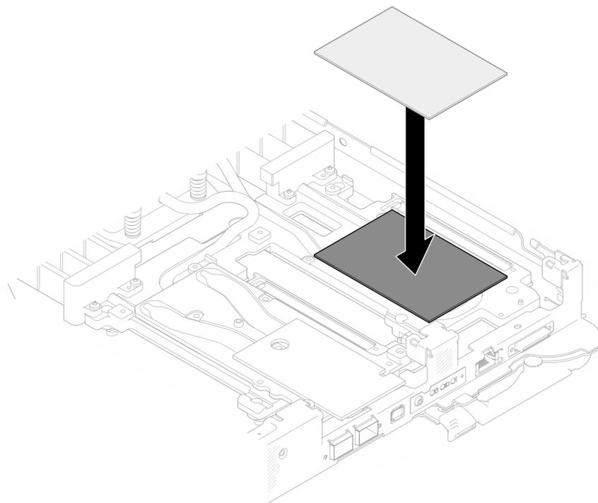
図139. ギャップ・パッドの交換
