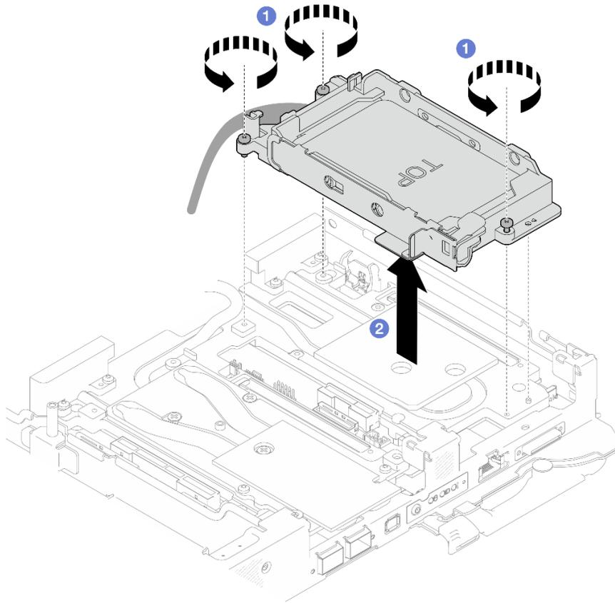
図 88. 1 個の 7 mm ドライブ・ケージ・アセンブリーの取り外し
