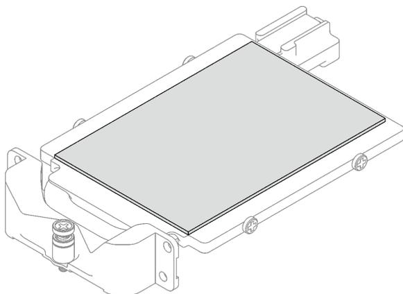
図131. 導電プレートのギャップ・パッドの交換
