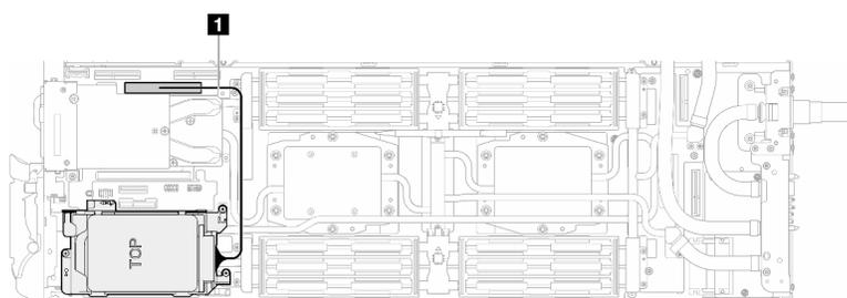
図 106. ドライブ・ケージ・ケーブルの接続
