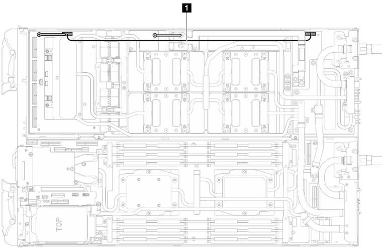
図319. キャリア・ボード電源ケーブルの接続
