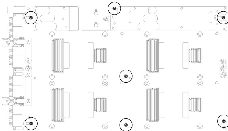
図 356. GPU ボードの M3 ねじの取り外し
