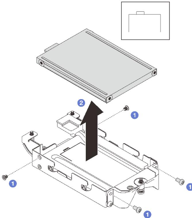
図 127. 下部 E3.s ドライブの取り外し
