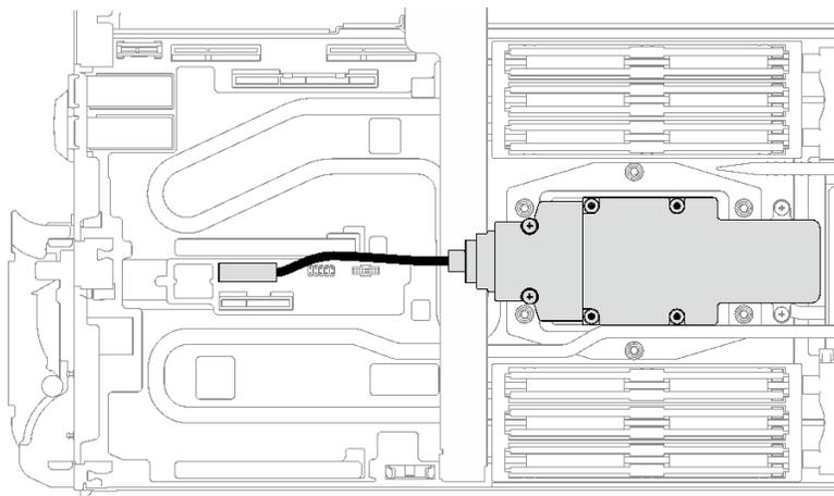
図 151. M.2 バックプレーン・アセンブリー・ケーブルの取り付け
