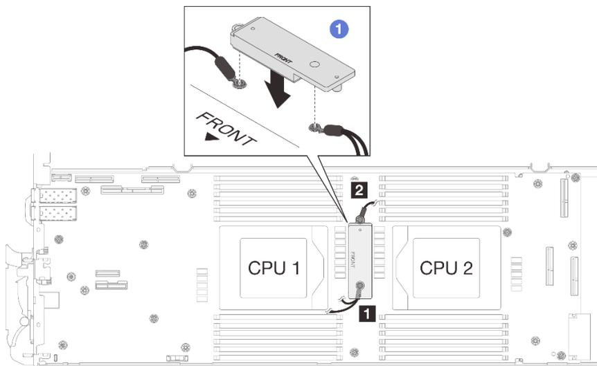
図 280. VR 伝導プレート、遮蔽ケーブル、およびシステム・ボードのねじ穴の位置合わせ
