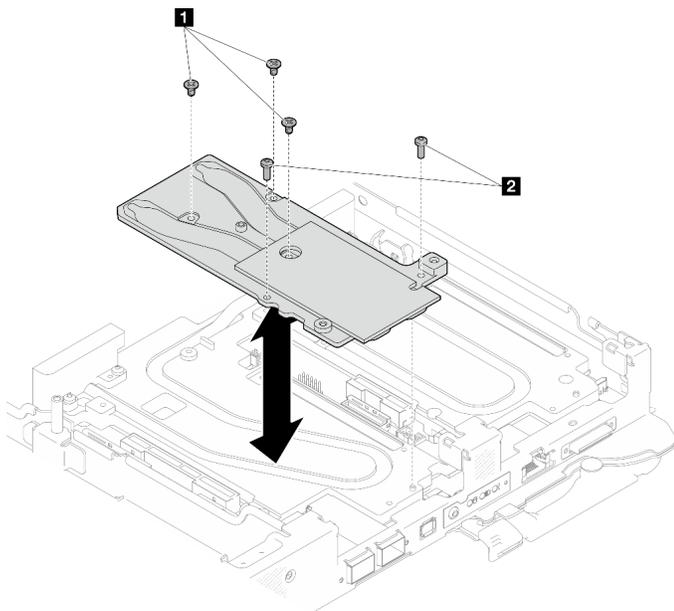
図 58. OSFP モジュール 伝導プレートの取り付け
