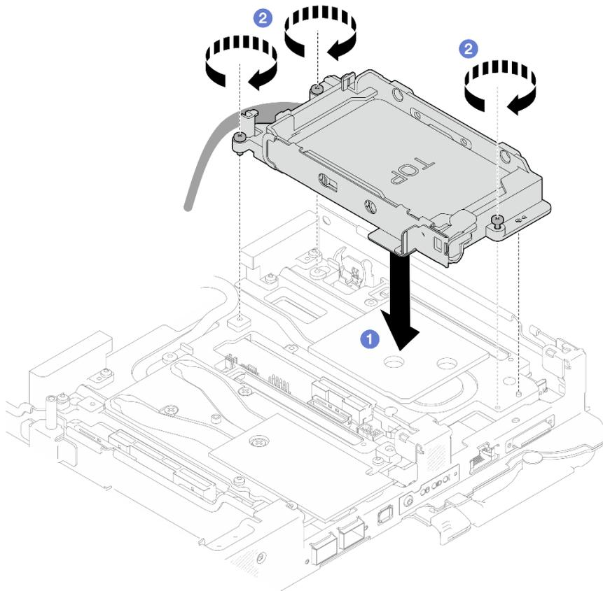
図 104. 1 個の 7 mm ドライブ・ケージ・アセンブリーの取り付け
