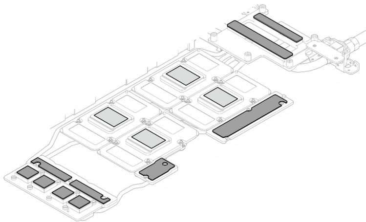
図435. ウォーター・ループのパテ・パッドの交換 (GPU ノード)
