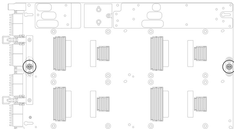
図 357. GPU ボードの T15 ねじの取り外し
