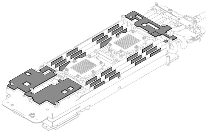
図 196. ウォーター・ループ・ギャップ・パッド (底面)
