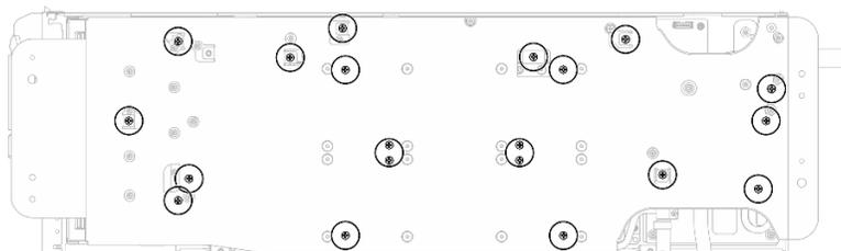
図60. ウォーター・ループのねじとクイック・コネクットのねじの取り付け (GPU ノード)
