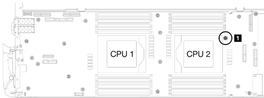
図 300. 遮蔽ケーブル 4 のねじ穴の位置
