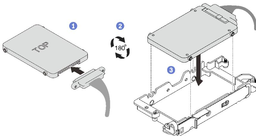
図98. 下段ドライブの取り付け (7mm ドライブ)
