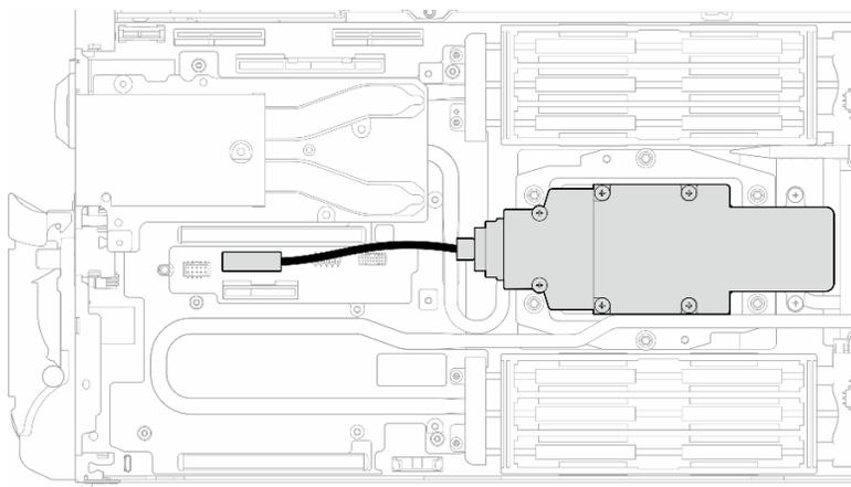
図142. M.2バックプレーン・アセンブリー・ケーブルの取り外し
