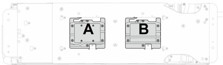
図 53. プロセッサ・コールド・プレートの取り付け
