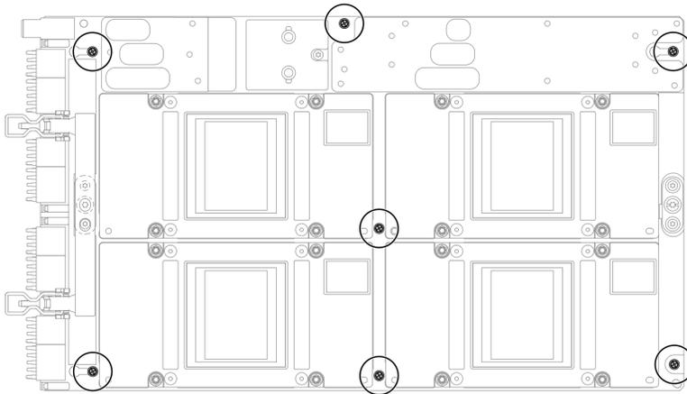
図 370. GPU ボード・アセンブリーの M3 ねじの取り外し
