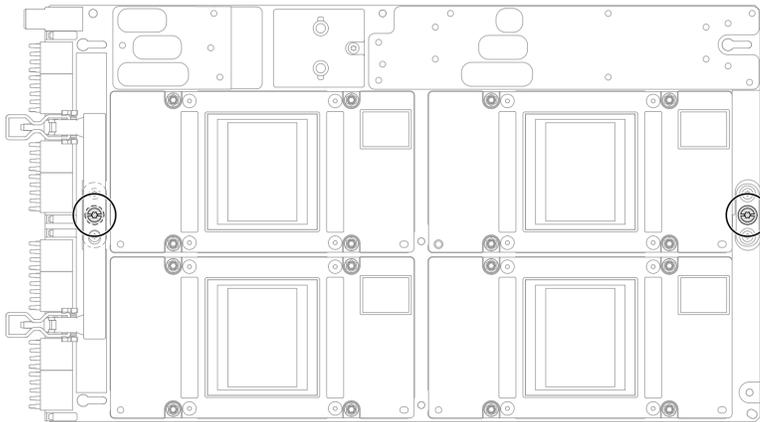
図 376. GPU ボード・アセンブリーへの T15 ねじの取り付け
