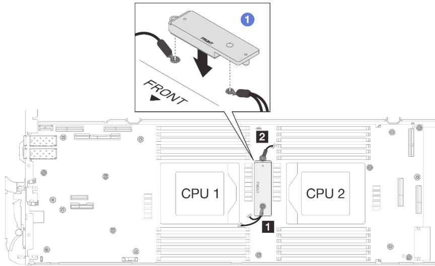
図 297. VR 伝導プレート、遮蔽ケーブル、およびシステム・ボードのねじ穴の位置合わせ
