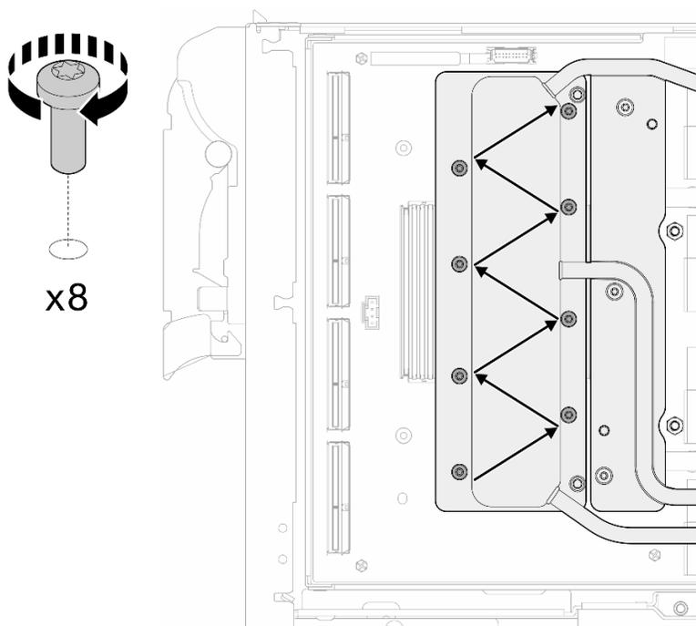
図408. ネットワーク・カードねじの取り付け
