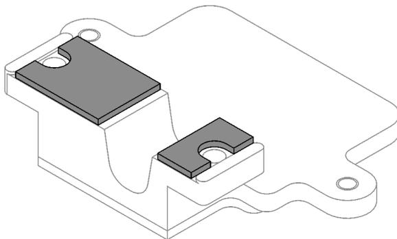
図 147. M.2 バックプレーン・コールド・プレートのパテ・パッド (底面)
