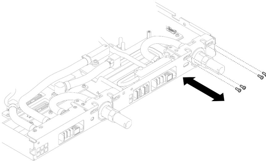
図 385. クイック・コネクットのねじの取り外し (GPU ノード)
