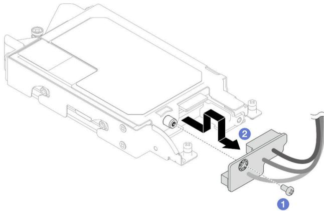
図 126. E3.s ドライブ・ケーブル・エンド・バックプレーンの取り外し
