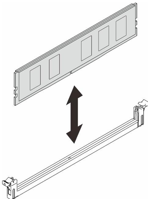
図 163. メモリー・モジュールの取り付け
