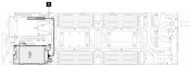
図 107. ドライブ・ケーブルの取り外し
