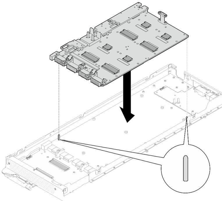
図 361. GPU ボードの取り付け
