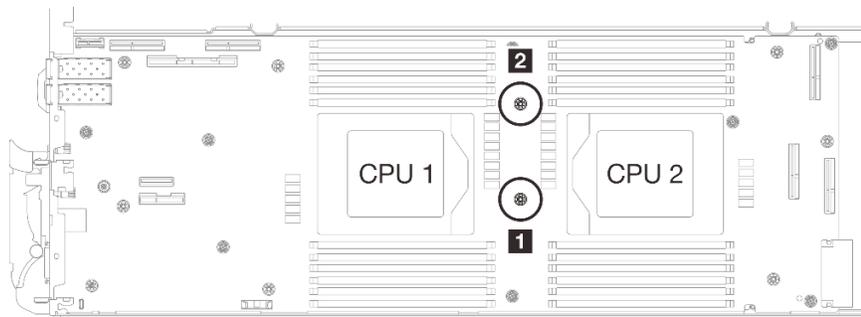
図 278. 遮蔽ケーブル 1/2 および 3 のねじ穴の位置
