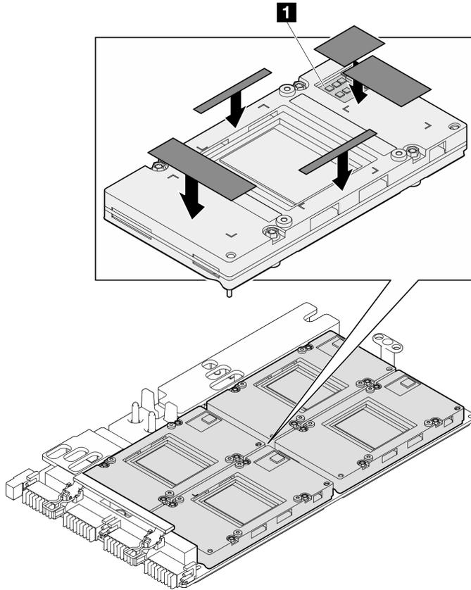
図 403. GPU パテ・パッドの交換
