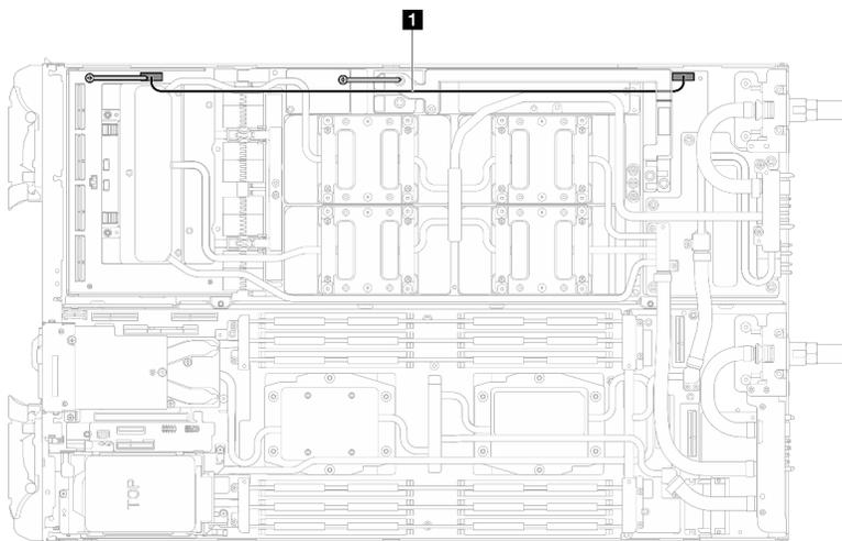
図 11. キャリア・ボードの電源ケーブルの取り外し
