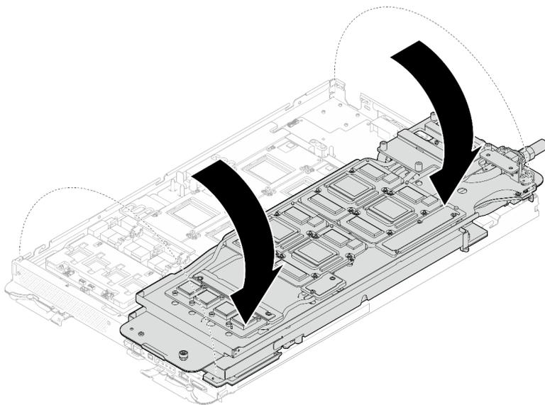
図 393. GPU ノード側のウォーター・ループを計算ノード側のウォーター・ループに折りたたむ
