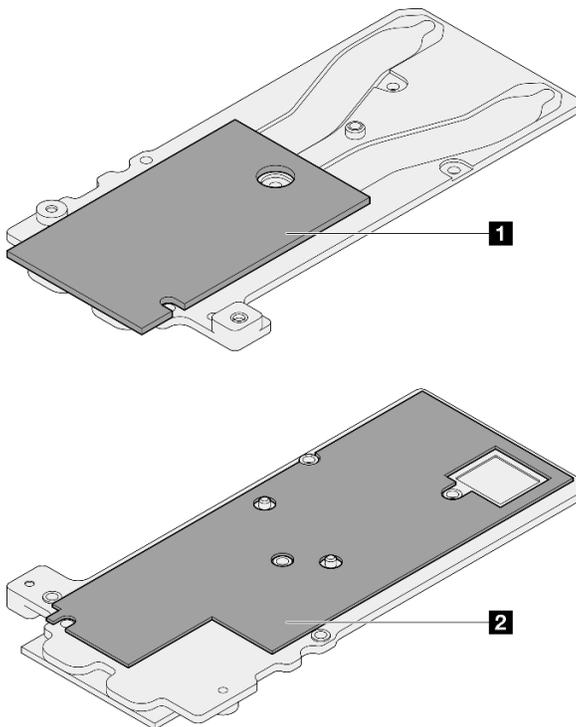
図 207. OSFP モジュールの伝導プレートのパテ・パッドの交換
