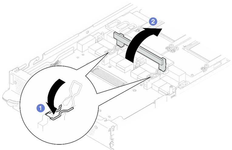
図 317. GPU ボードへのキャリア・ボードの固定
