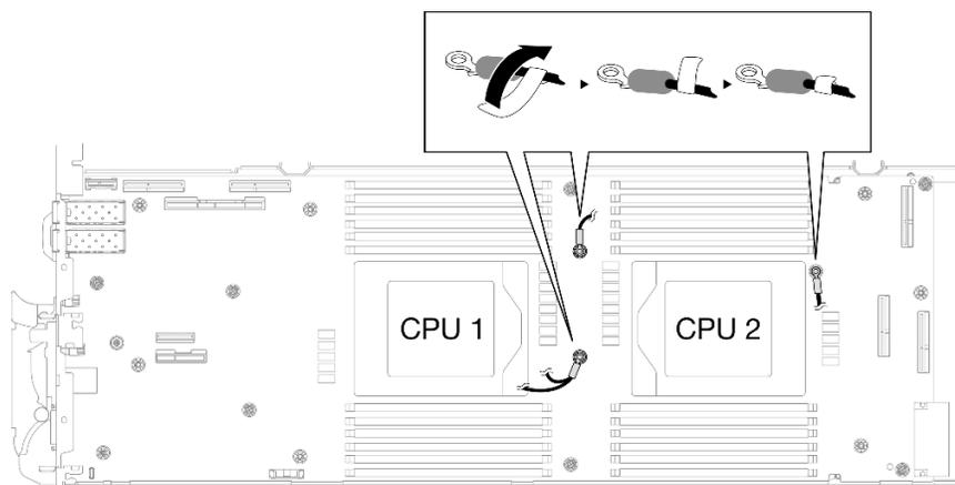
図 285. 遮蔽ケーブルへのラベルの巻き付け
