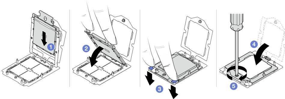
図224. プロセッサの取り付け
