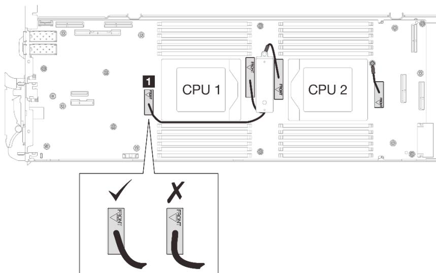
遮蔽ケーブル 4 は、CPU 2 に対して斜めに配置します。
