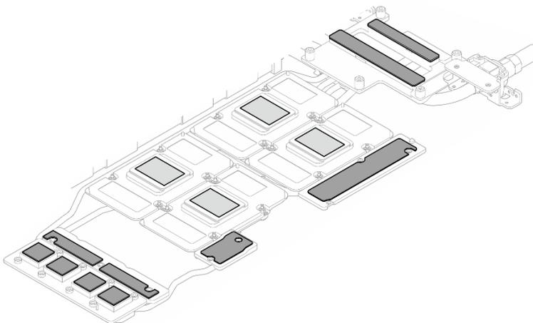
図 402. ウォーター・ループのパテ・パッドの交換 (GPU ノード)
