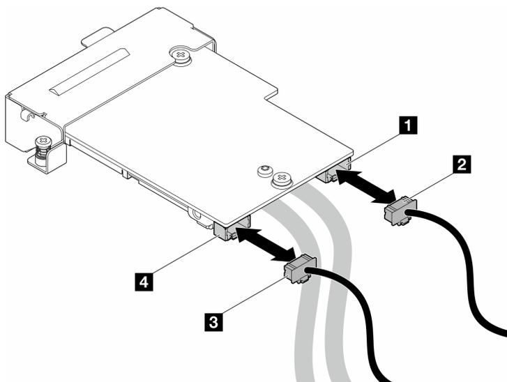
図 175. OSFP モジュール電源ケーブルの取り付け
