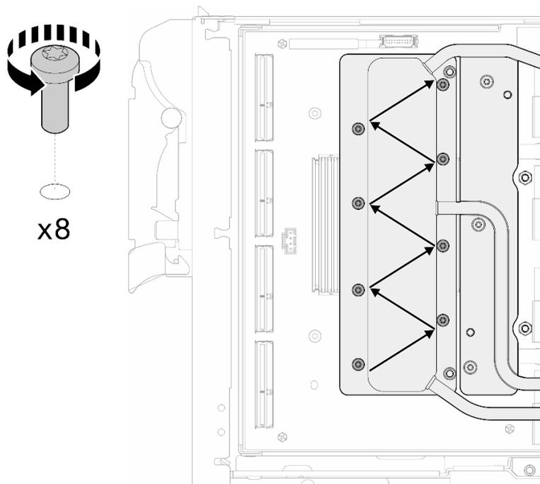
図326. ネットワーク・カードのねじの取り外し
