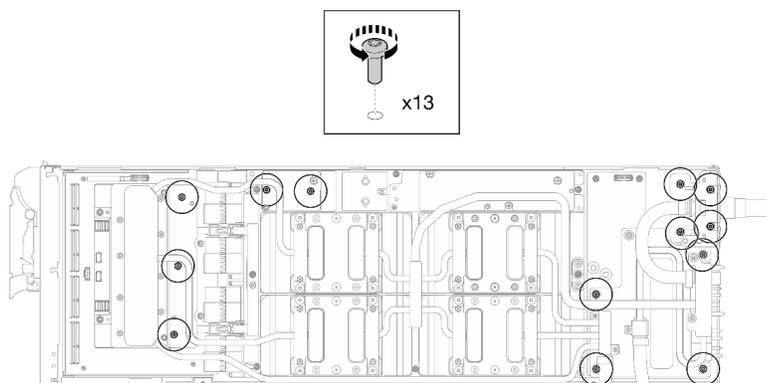
図418. ウォーター・ループの Torx T10 ねじの取り外し (GPU ノード)
