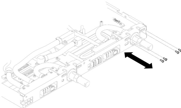
図 64. クイック・コネクットのねじの取り付け (GPU ノード)
