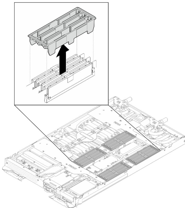
図 161. DIMM カバーの取り外し
