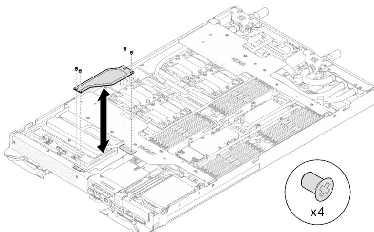
図10. 前面ケーブル・カバーの取り付け
