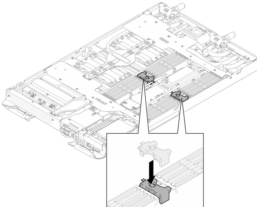
図 85. DIMM コームの取り付け
