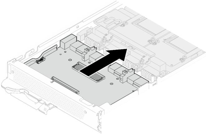
図 364. GPU ボードへの キャリア・ボード の接続。
