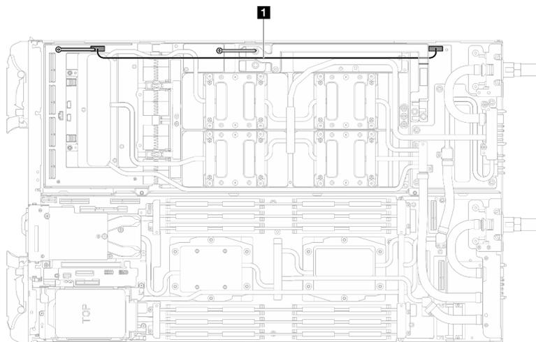
図 352. キャリア・ボード電源ケーブルの接続
