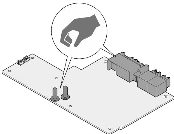
図 398. SD665-N V3 GPU 分電盤のタッチ・ポイント
