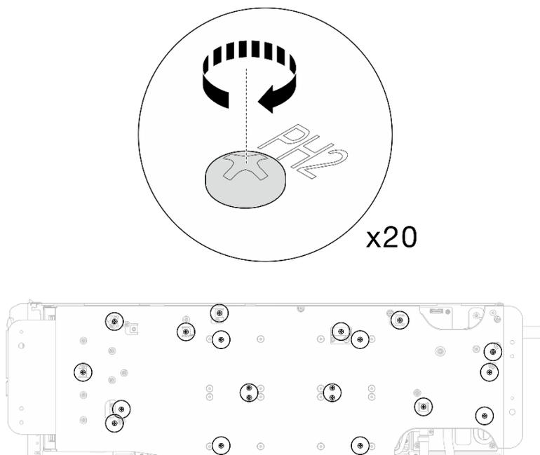
図 392. ウォーター・ループねじおよびクイック・コネクトねじの取り外し (GPU ノード)
