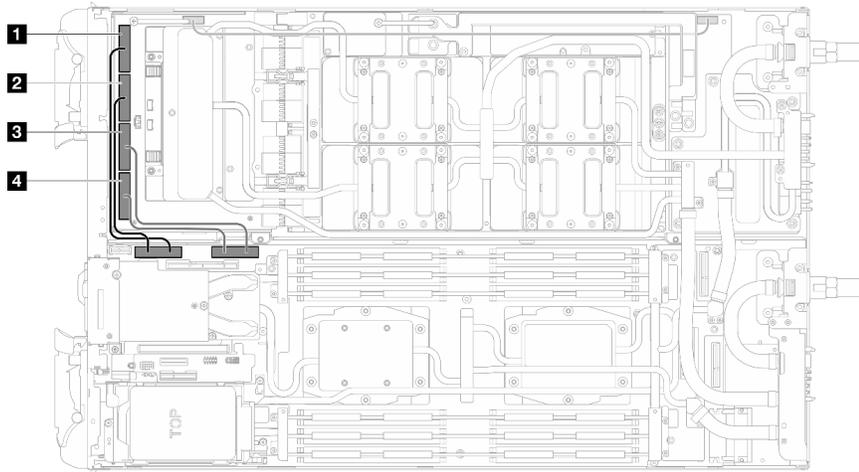
図 178. 1 プロセッサ構成 - すべての MCIO ケーブルをキャリア・ボードに接続
