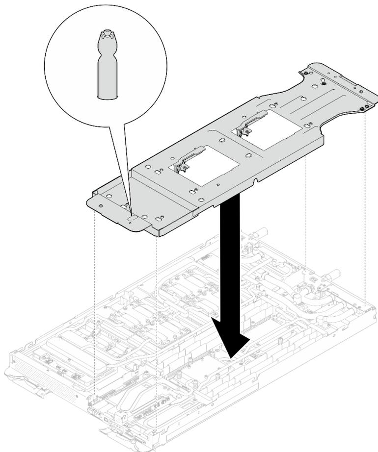
図 34. ウォーター・ループ・キャリアの取り付け (計算ノード)
