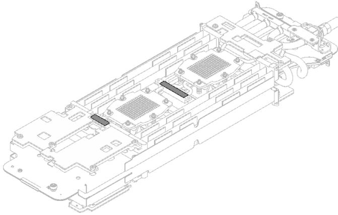
図 43. ウォーター・ループ底面のパテ・パッド (計算ノード側)
