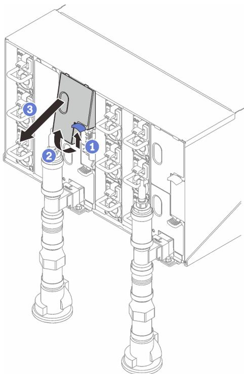
図 466. 上段の EMC シールドの取り外し
