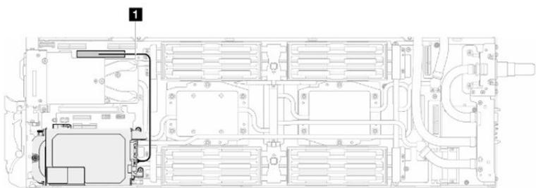
図 181. E3.S ドライブ・ケーブルの接続
