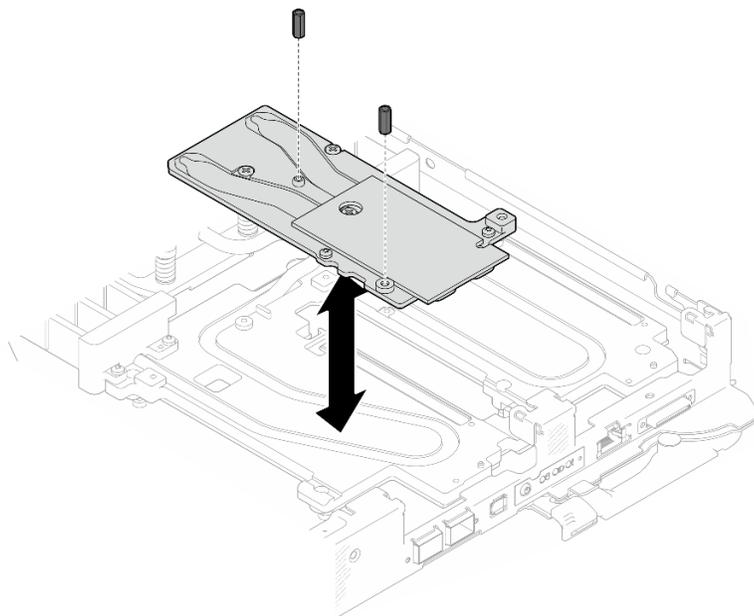
図 211. OSFP モジュール 伝導プレートの六角ねじの取り外し
