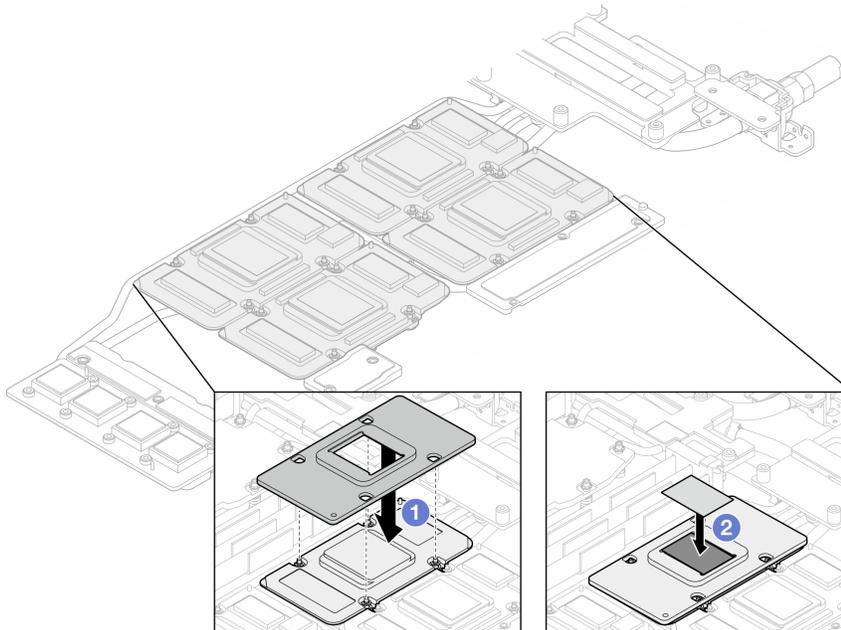
図46. ウォーター・ループ GPU コールド・プレート PCM の交換 (GPU ノード)
