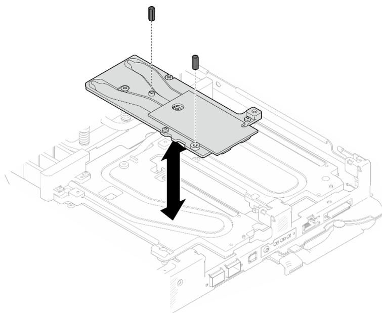
図 241. OSFP モジュール 伝導プレートの六角ねじの取り外し
