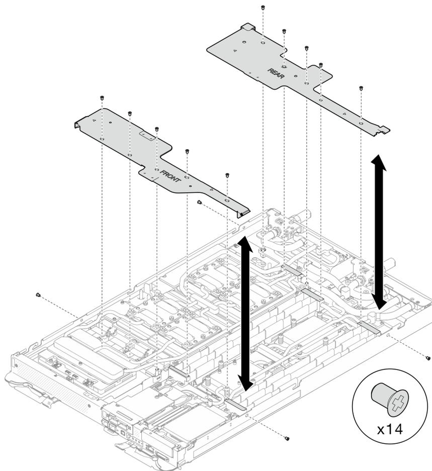
図8. 前面と背面のクロス・ブレースの取り外し
