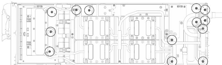
図 443. ウォーター・ループ Torx T10 ねじの取り付け (GPU ノード)
