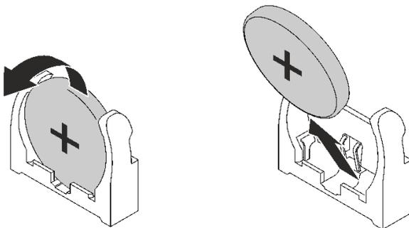
図 80. CMOS バッテリーの取り外し
