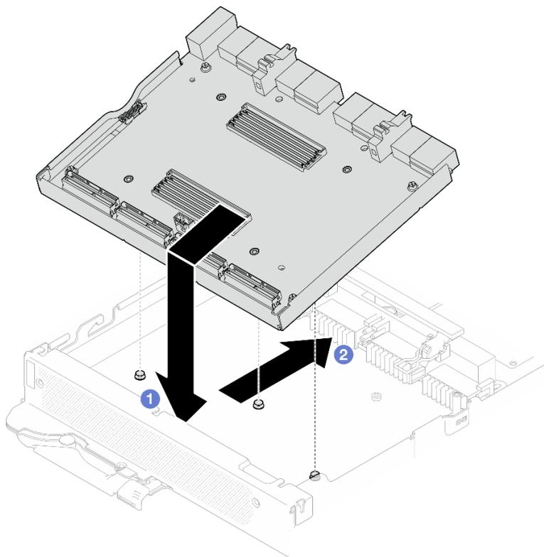
図 316. キャリア・ボードの取り付け
