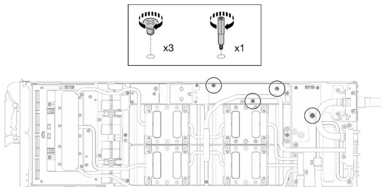
図 66. ウォーター・ループ六角ねじおよび PH1 ねじの取り付け (GPU ノード)
