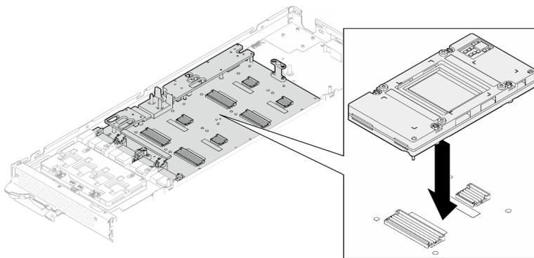
図 338. GPU の取り付け
