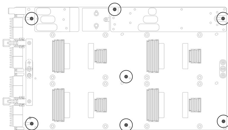
図362. GPU ボードへの M3 ねじの取り付け
