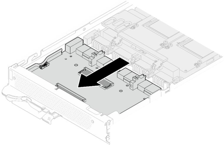
図 369. GPU ボードからのキャリア・ボードの取り外し
