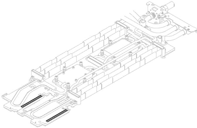
図 228. ウォーター・ループ・ギャップ・パッド (上面)
