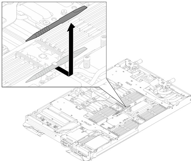
図 153. メモリー・モジュール・ツールの取り外し
