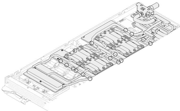
図 423. GPU コールド・プレートを取り外すための切り欠き
