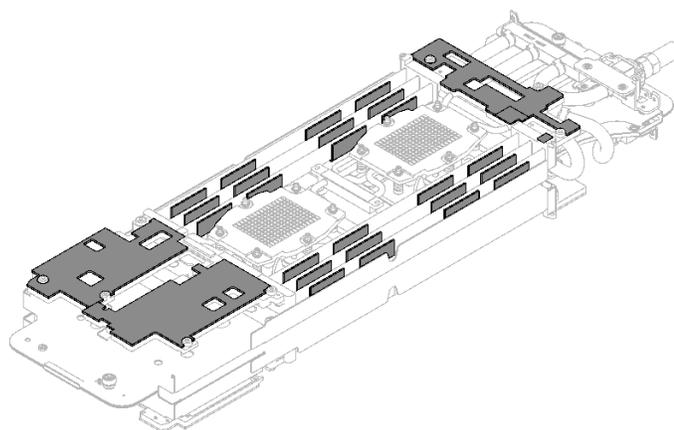
図227. ウォーター・ループ・ギャップ・パッド (底面)
