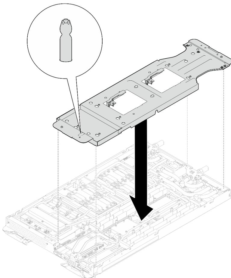
図 248. ウォーター・ループ・キャリアの取り付け (計算ノード)
