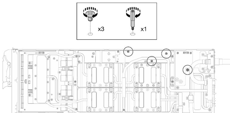
図411. ウォーター・ループ六角ねじおよびPH1ねじの取り付け (GPU ノード)
