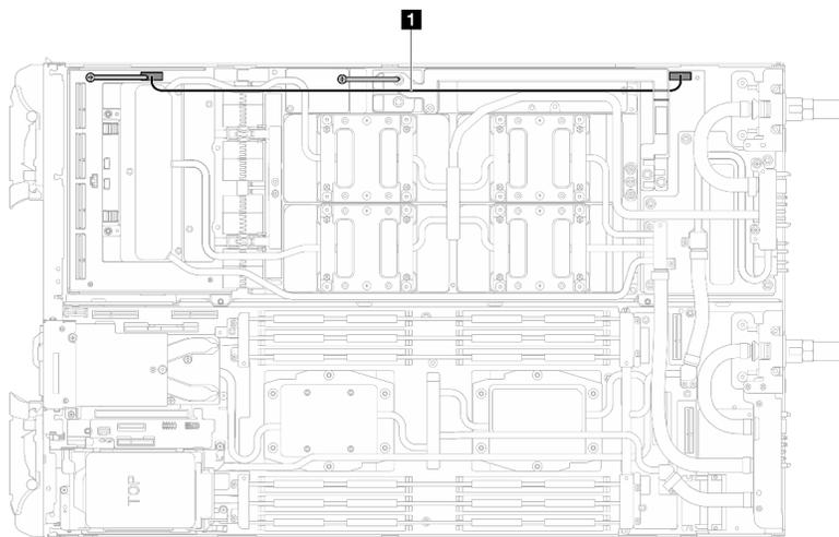
図 68. キャリア・ボード電源ケーブルの接続
