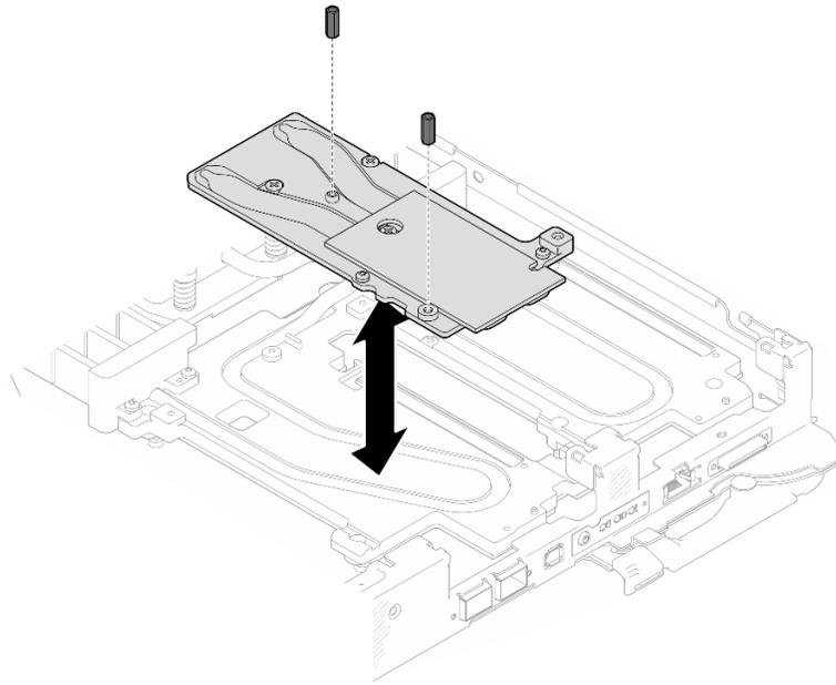
図 209. OSFP モジュール 伝導プレートの六角ねじの取り付け
