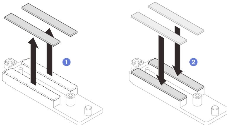
図 305. VR 伝導プレートのパテ・パッドの交換
