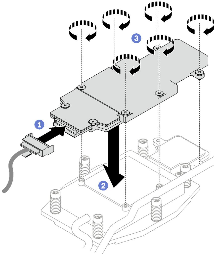
図 150. M.2 バックプレーン・アセンブリーの取り付け
