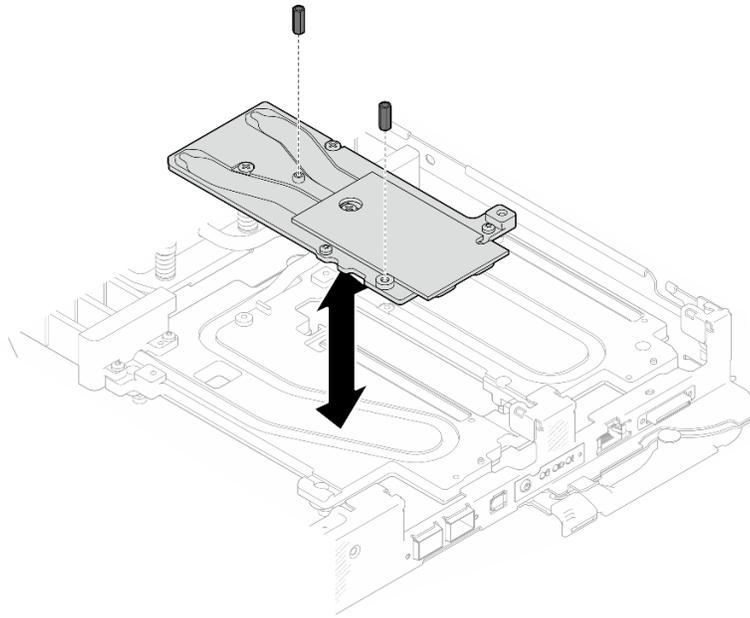
図269. OSFP モジュール 伝導プレートの六角ねじの取り付け
