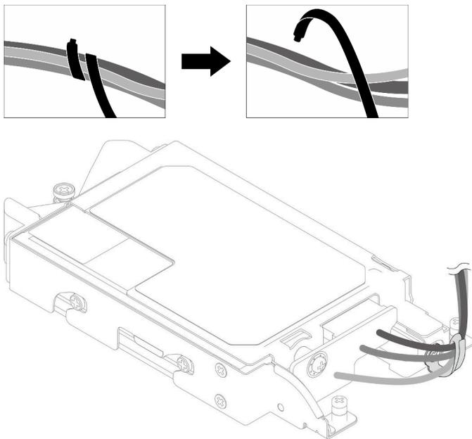
図124. ケーブル・タイからのケーブルの取り外し
