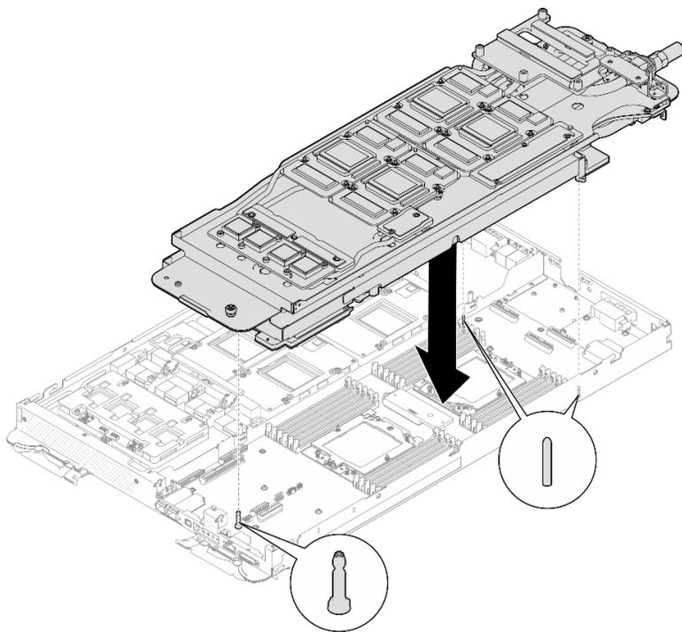
図49. ウォーター・ループ・キャリアの取り付け
