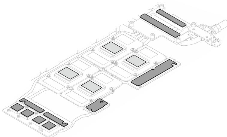
図47. ウォーター・ループのパテ・パッドの交換 (GPU ノード)
