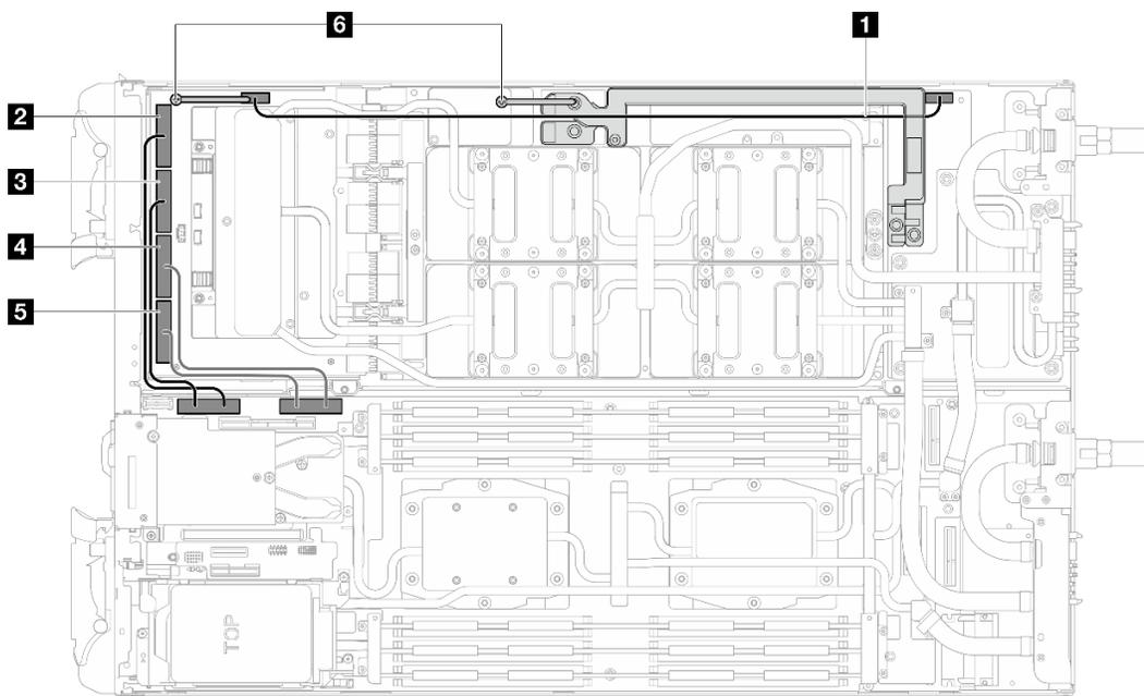
図 452. 1 プロセッサ構成のケーブル配線
