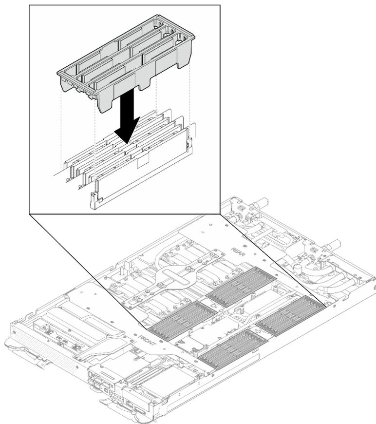
図 157. DIMM カバーの取り付け
