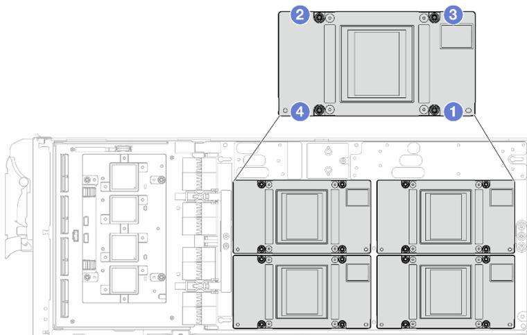
図 339. GPU ネジの締め付け順序
