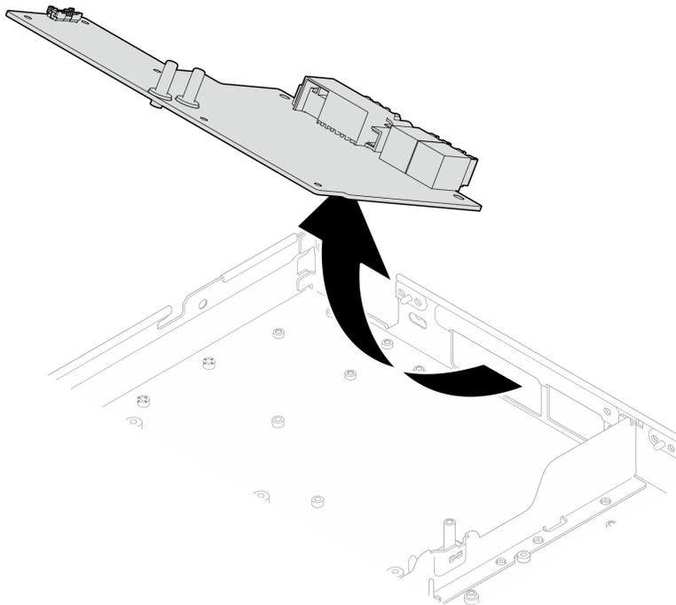
図 397. GPU 分電盤の取り外し
