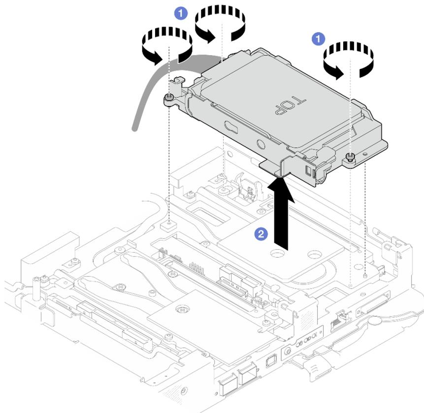
図89. 2個の7mmドライブ・ケージ・アセンブリの取り外し
