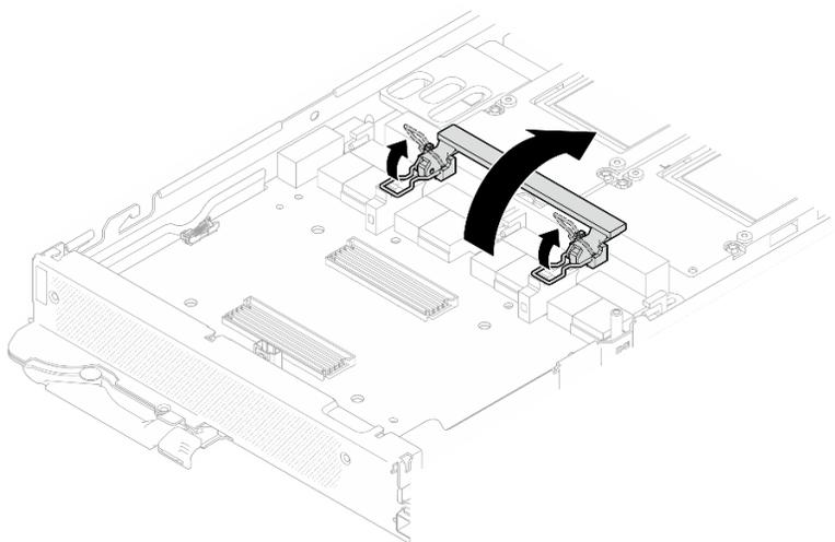
図 315. GPU ボード保持クリップおよびハンドルの回転
