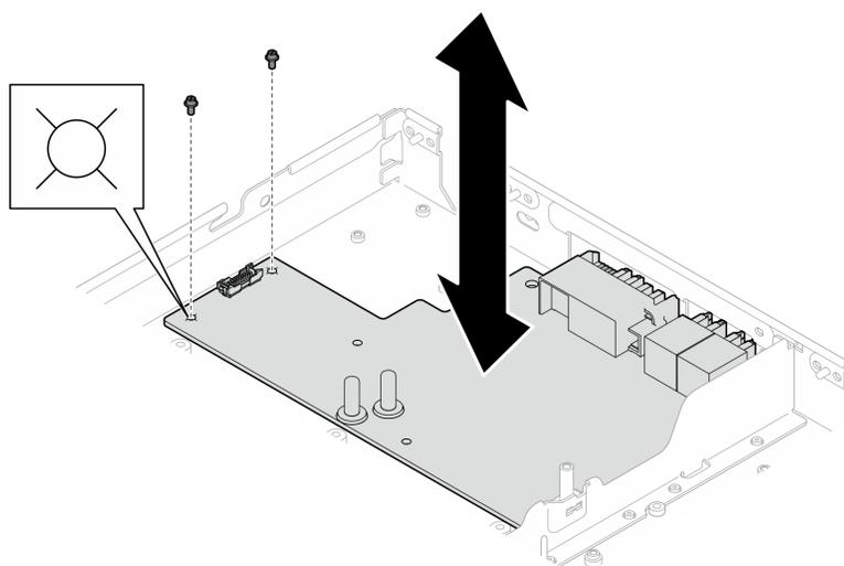
図 400. GPU 分電盤のねじの取り付け
