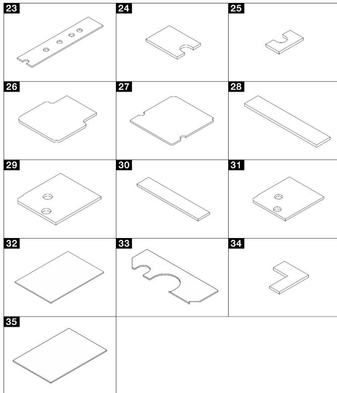
表 4. 計算ノードのコンポーネント - ギャップ・パッド/パテ・パッドの識別と位置
