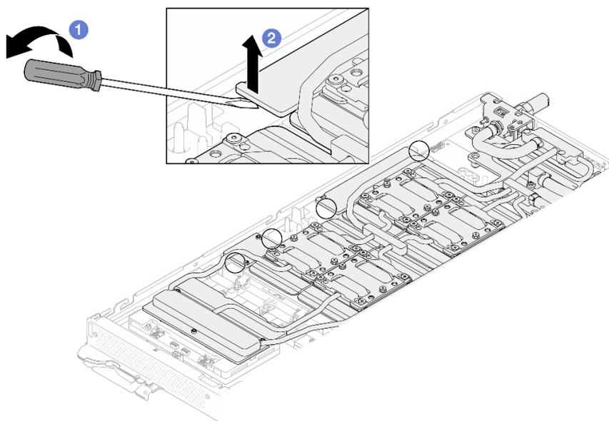
図 422. GPU ボードからの前面と背面の MISC 伝導プレートの取り外し
