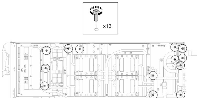
図 65. ウォーター・ループ Torx T10 ねじの取り付け (GPU ノード)
