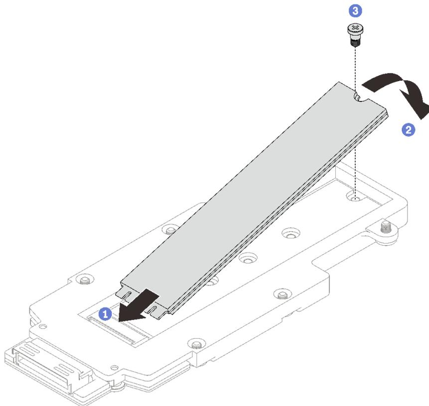
図 146. M.2 ドライブの取り付け
