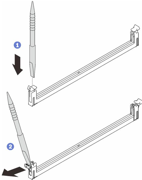
図 155. メモリー・モジュールの取り外し
