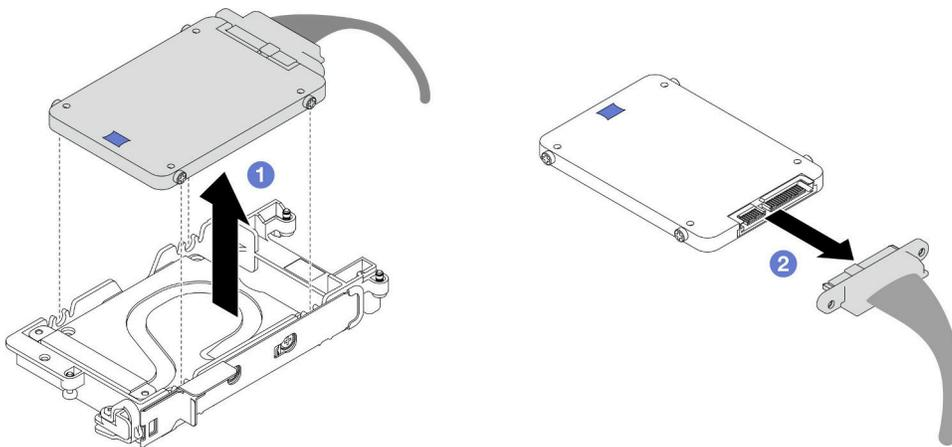
図111. 下段ドライブの取り外し
