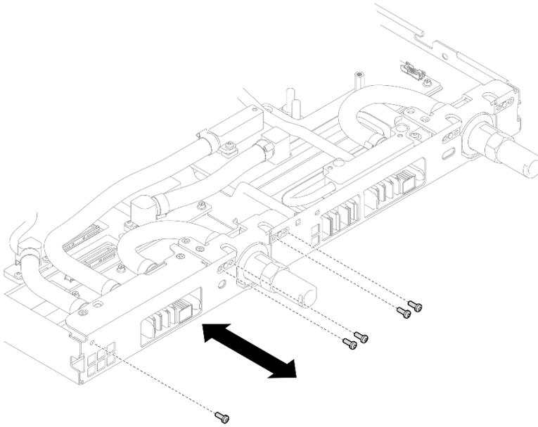
図184. クイック・コネクットのねじの取り外し (計算ノード)
