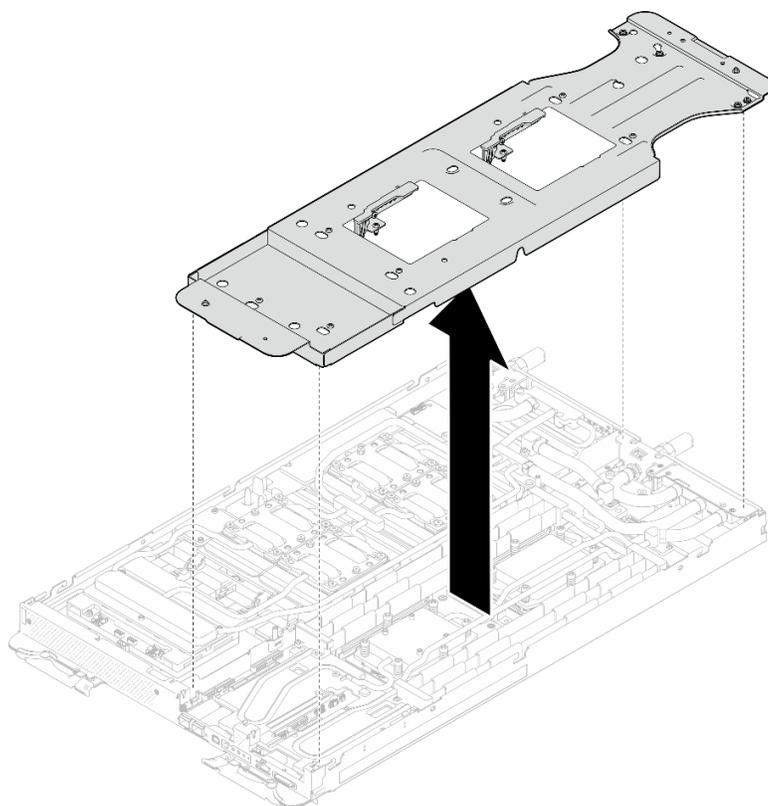
図 262. ウォーター・ループ・キャリアの取り外し (計算ノード)
