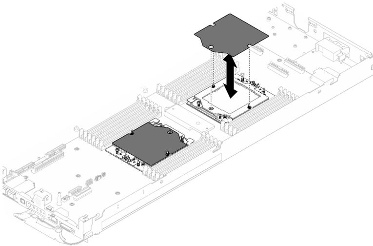
図252. プロセッサ・ソケット保護フィルムの取り外し
