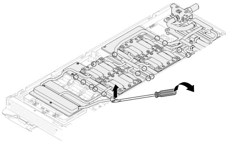
図 20. GPU からの GPU コールド・プレートの取り外し
