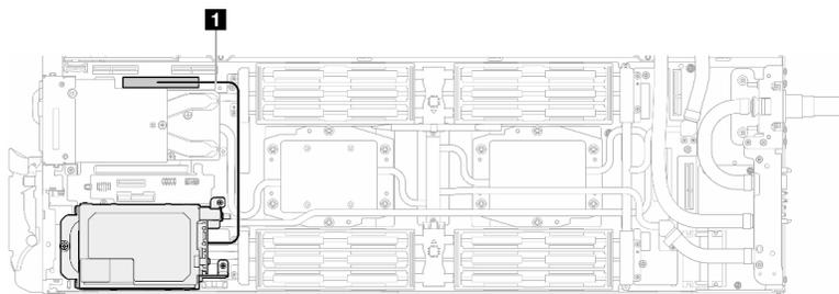
図 167. E3.S ドライブ・ケーブルの取り外し
