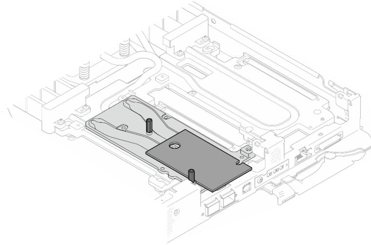
図 174. OSFP モジュールのパテ・パッドの交換
