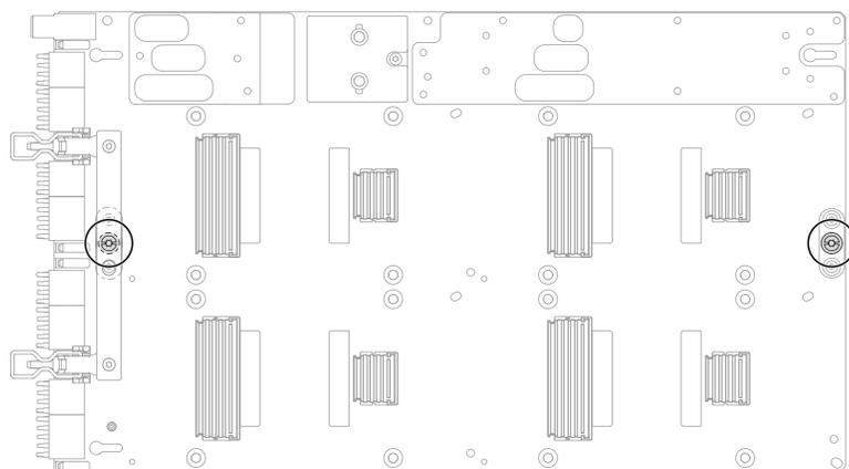
図363. GPU ボードへの T15 ねじの取り付け
