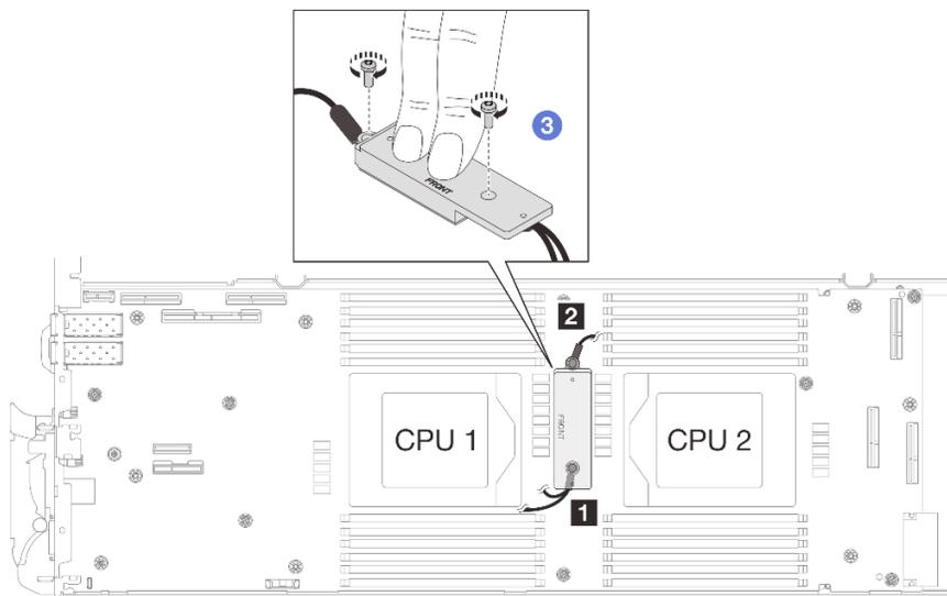
図 282. 遮蔽ケーブル 1/2 および 3 の取り付け
