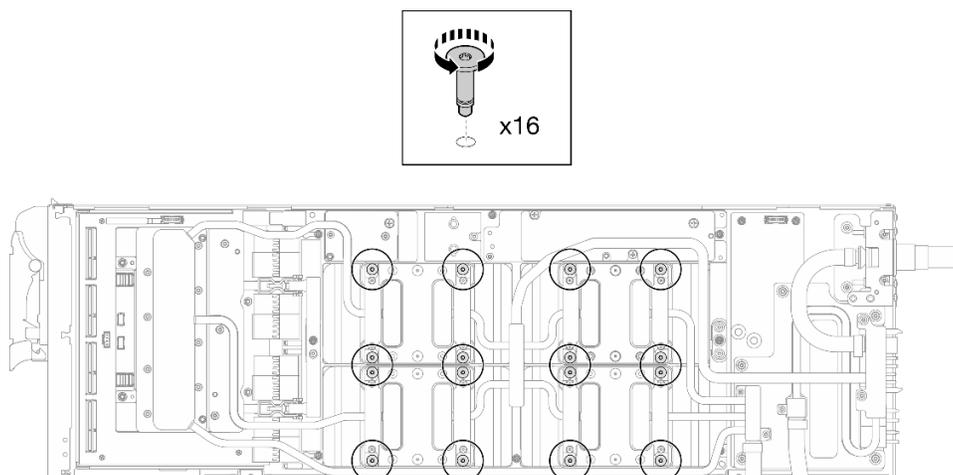
図 387. GPU コールド・プレートねじを緩める
