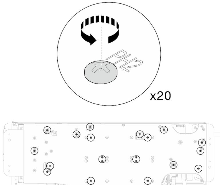
図 438. ウォーター・ループのねじとクイック・コネクットのねじの取り付け (GPU ノード)
