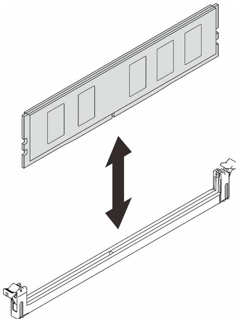
図 156. メモリー・モジュールの取り外し
