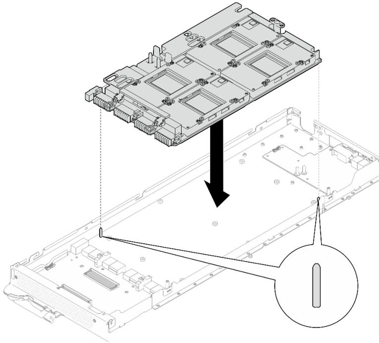
図374. ノードへの GPU ボード・アセンブリーの取り付け
