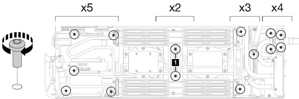
図 265. ウォーター・ループのねじとクイック・コネクットのねじの取り付け
