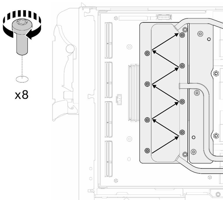
図441. ネットワーク・カードねじの取り付け
