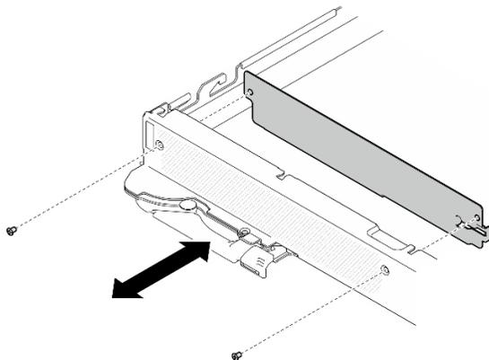
図 448. 通風口ブロックの取り外し
