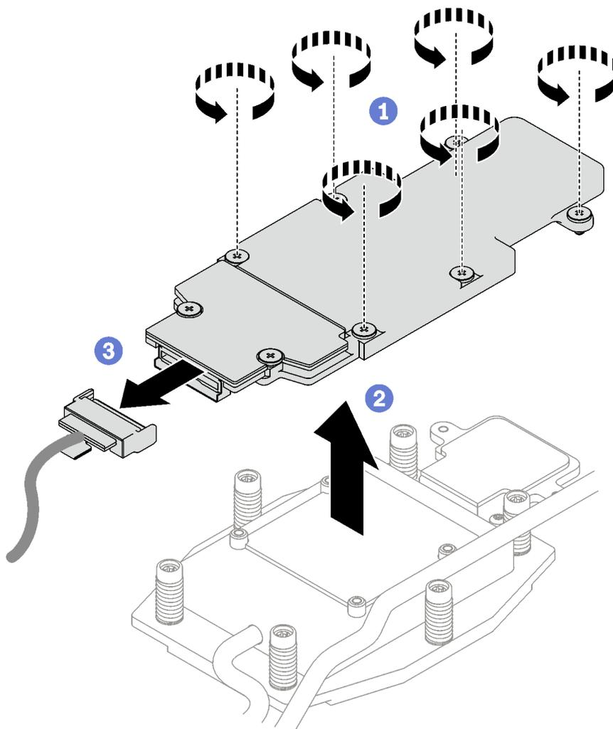
図 143. M.2 バックプレーン・アセンブリの取り外し
