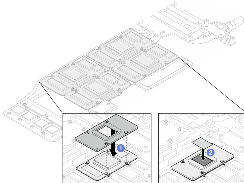
図434. ウォーター・ループ GPU コールド・プレート PCM の交換 (GPU ノード)
