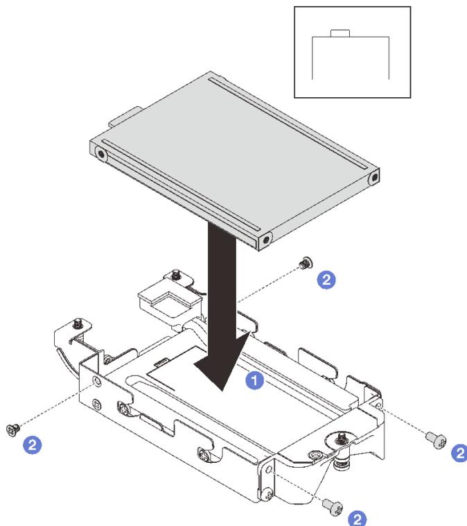
図134. 下部 E3.s ドライブの取り付け
