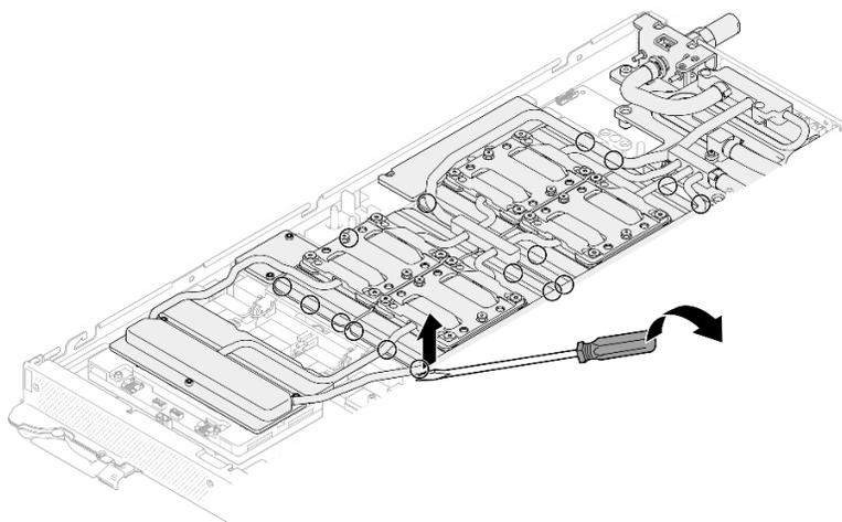
図 424. GPU からの GPU コールド・プレートの取り外し
