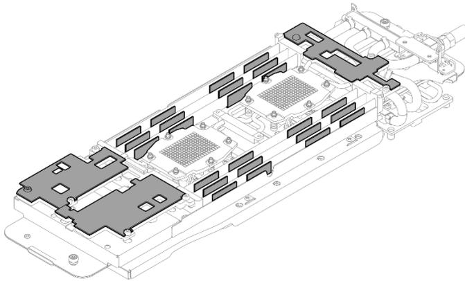
図 44. ウォーター・ループ底面のギャップ・パッド (計算ノード側)
