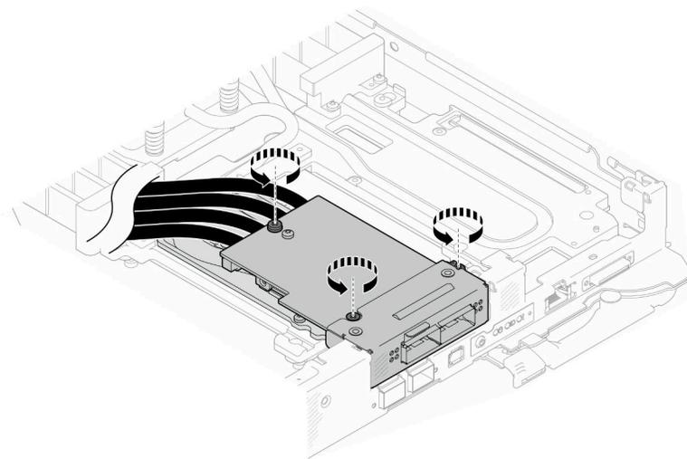
図 171. OSFP モジュールの取り外し
