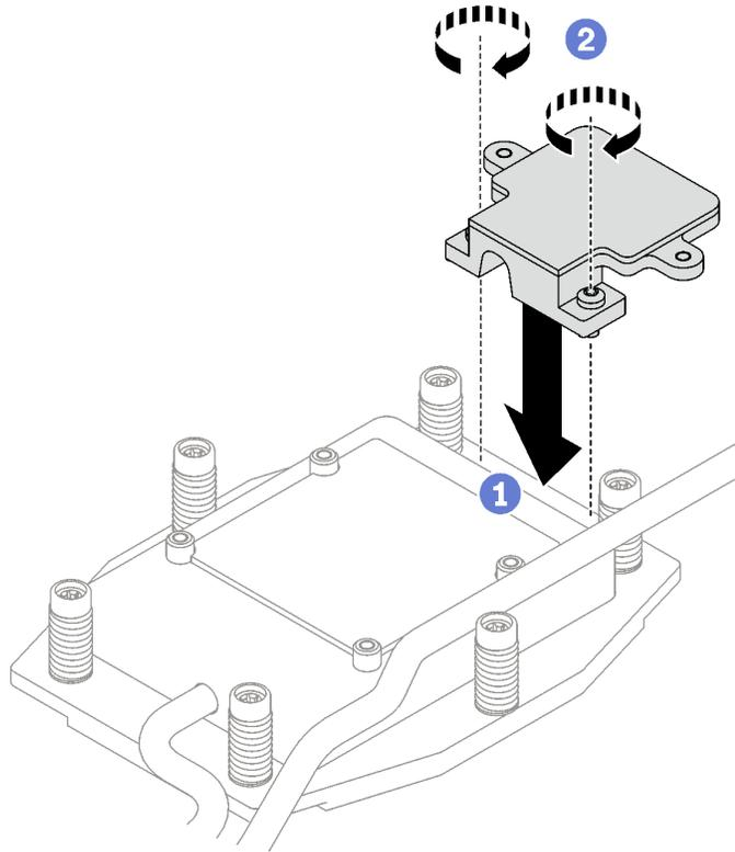
図 148. M.2 バックプレーン・コールド・プレートの取り付け
