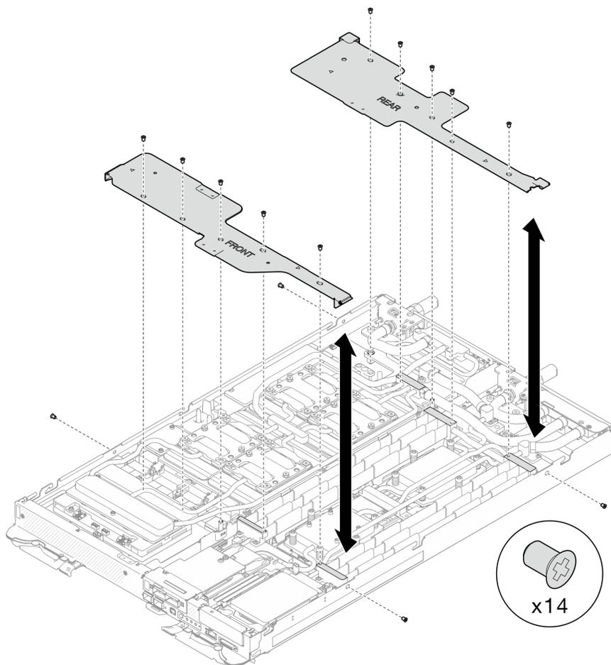
図9. 前面と背面のクロス・ブレースの取り付け
