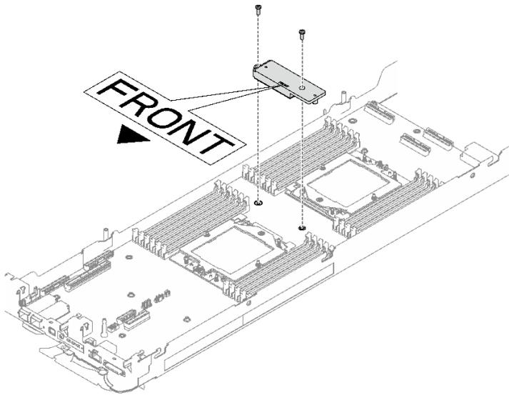
図 306. VR 伝導プレートの取り付け
