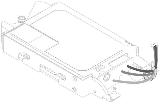
図 137. ケーブル・タイでケーブルを束ねる
