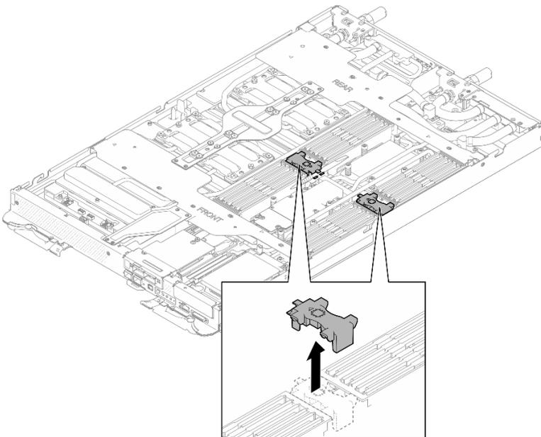
図 84. DIMM コームの取り外し
