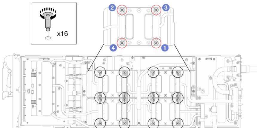
図407. GPU コールド・プレートのねじの取り付け
