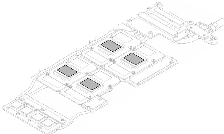
図 394. すべての GPU からの PCM のクリーニング
