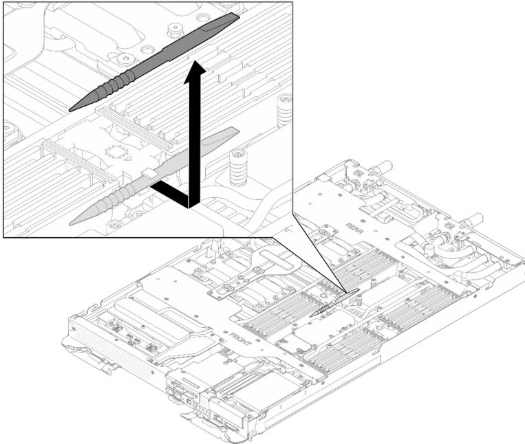
図 83. メモリー・モジュール・ツールの取り外し
