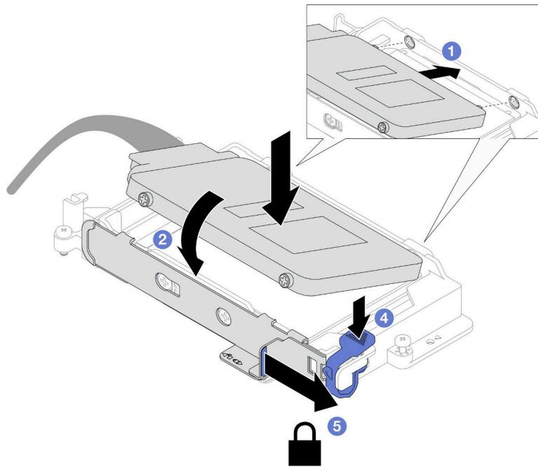
図115. 上段ドライブの取り付け
