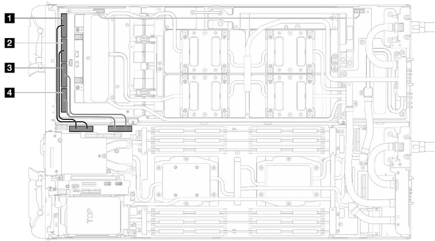
図 168. 1 プロセッサ構成 - すべての MCIO ケーブルを取り外す
