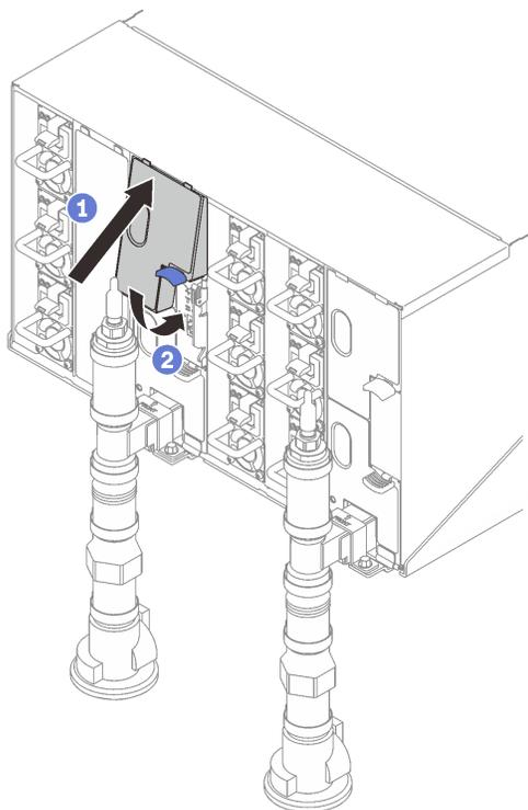
図 467. 上段の EMC シールドの取り付け
