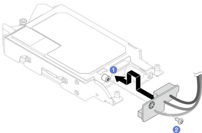
図135. E3.s ケーブル・エンド・バックプレーンの取り付け
