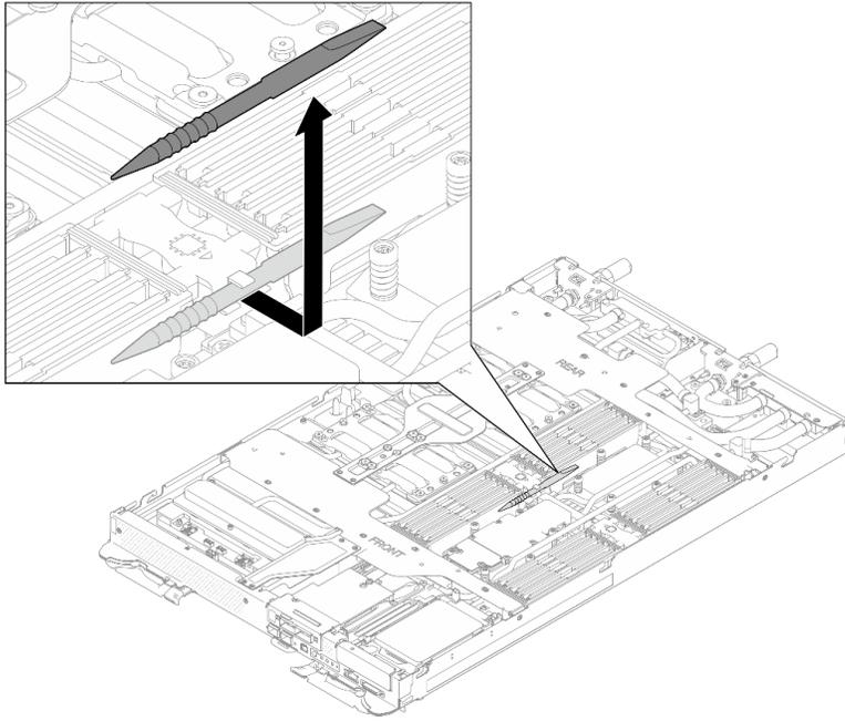
図 160. メモリー・モジュール・ツールの取り外し
