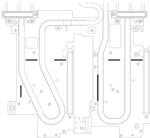
図102. ギャップ・パッドの位置合わせのためのウォーター・ループのマーキング
