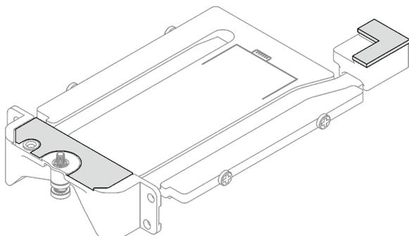
図132. 導電プレートのパテ・パッドの交換
