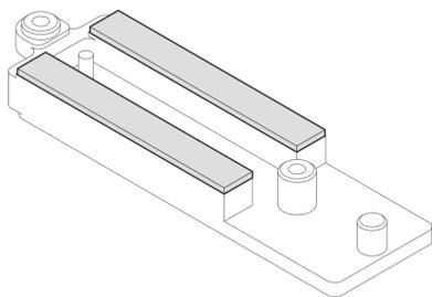
図 77. VR 伝導プレートの底面にあるパテ・パッド
