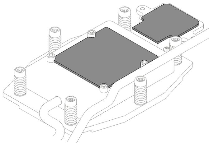
図 149. プロセッサ・コールド・プレートと M.2 コールド・プレートのパテ・パッド
