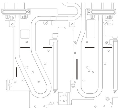
図117. ギャップ・パッドの位置合わせのためのウォーター・ループのマーキング
