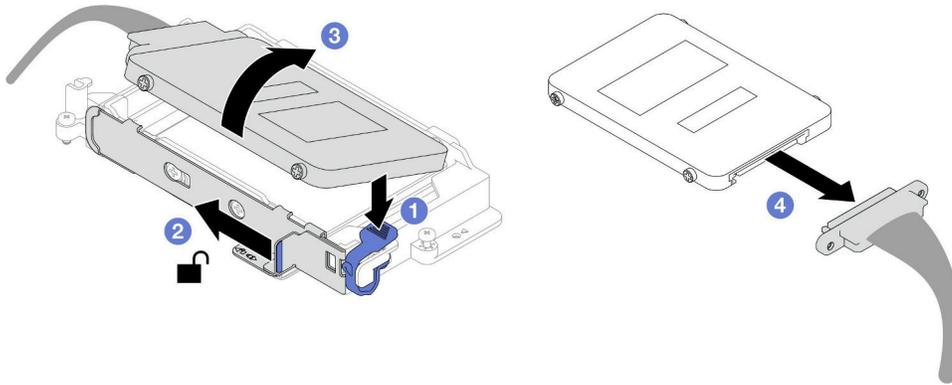
図110. 上段ドライブの取り外し (7mm NVMe)
