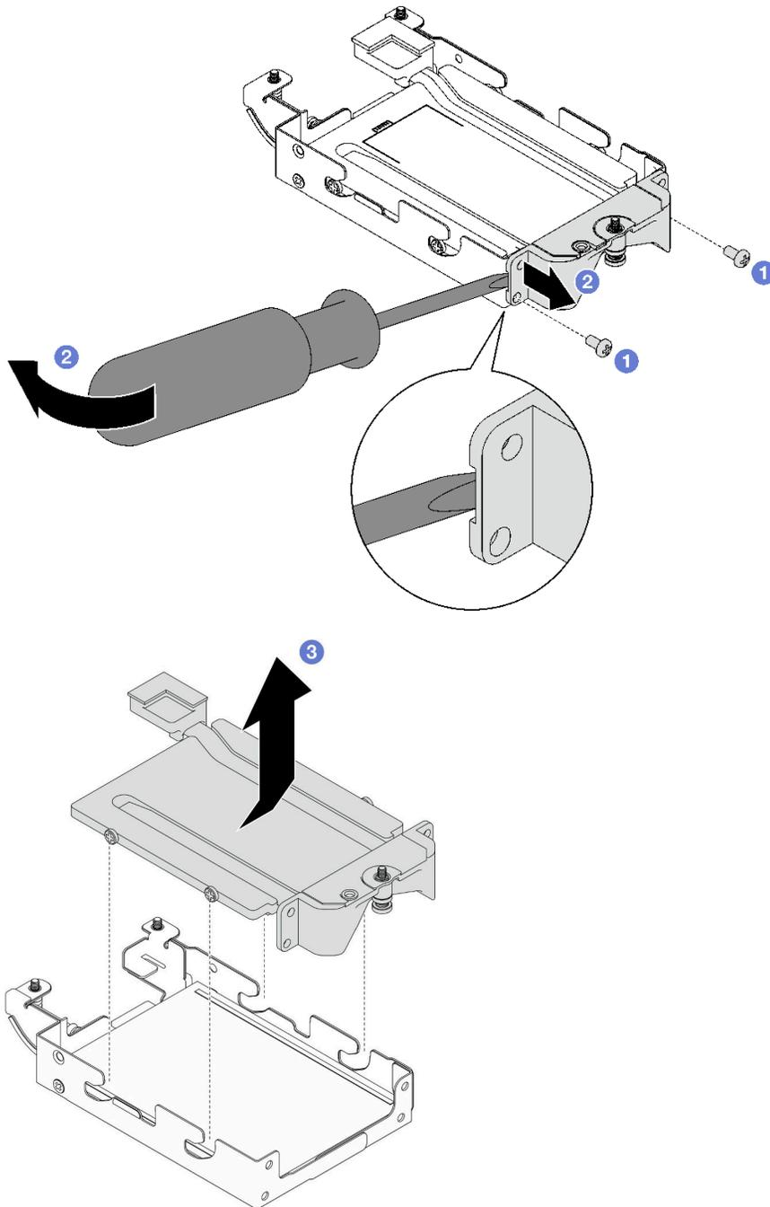
図128. 導電プレートの取り外し
