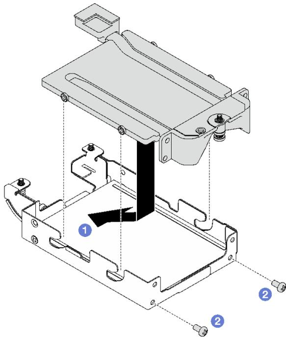
図 133. E3.s ドライブ導電プレートの取り付け
