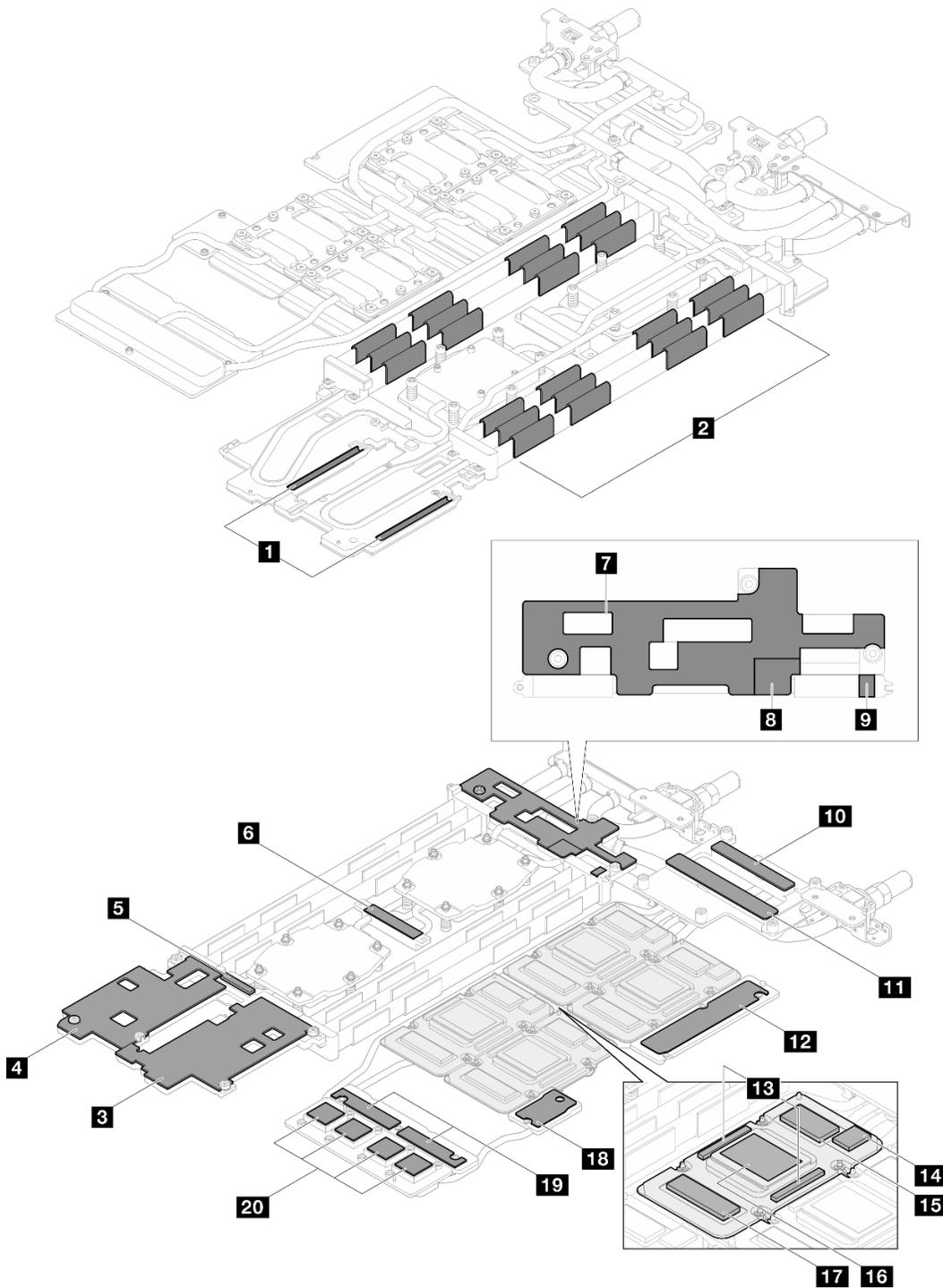
図2. ウォーター・ループおよび GPU ノード - ギャップ・パッド/パテ・パッドの識別と位置
