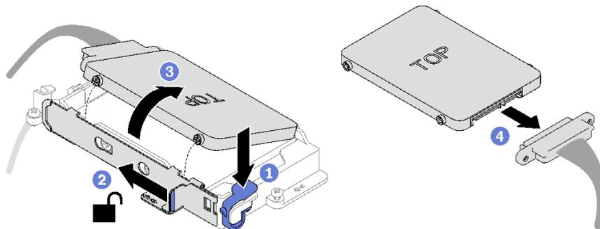
図92. 上段ドライブの取り外し
