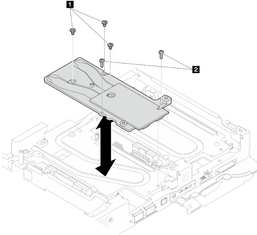
図28. OSFP モジュール 伝導プレートの取り外し
