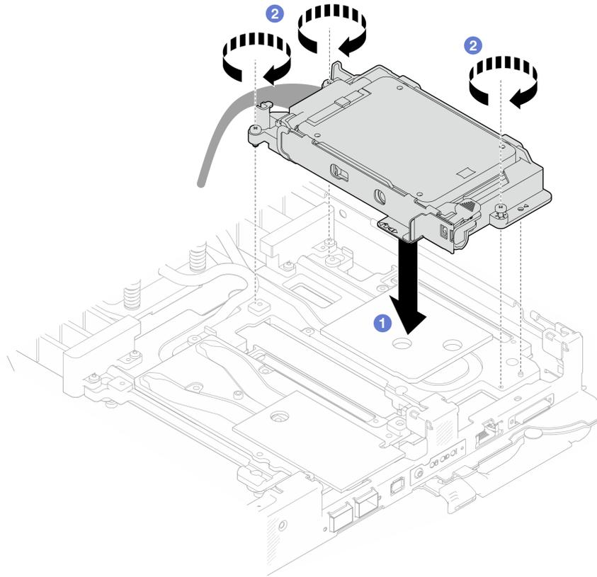
図 119. 7mm NVMe ドライブ・ケージ・アセンブリーの取り付け
