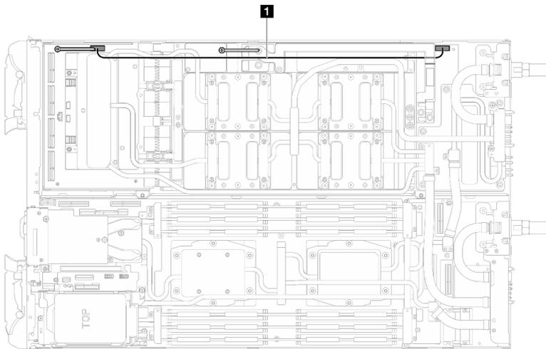
図 446. キャリア・ボード電源ケーブルの接続
