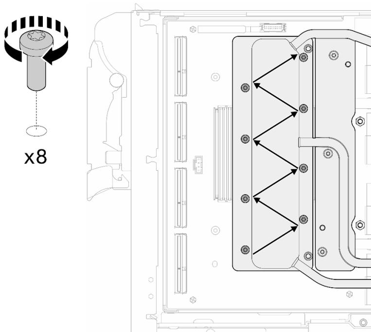
図 347. ネットワーク・カードねじの取り付け
