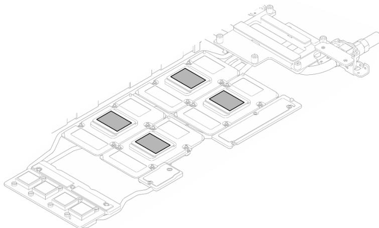
図 428. すべての GPU からの PCM のクリーニング
