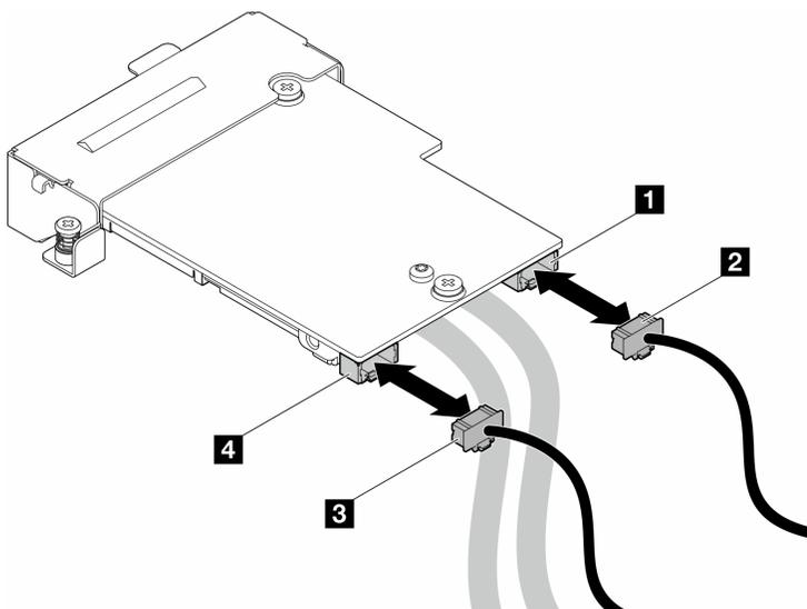
図 173. OSFP モジュール電源ケーブルの取り外し
