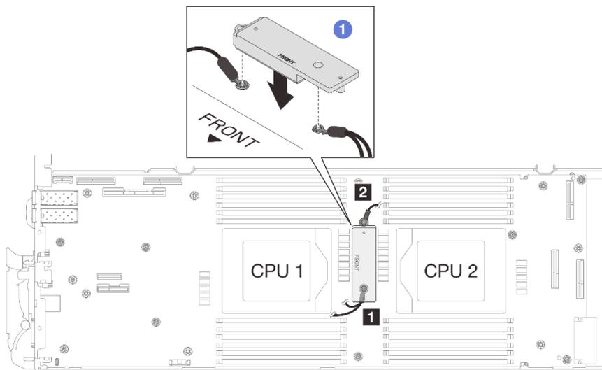
図 73. VR 伝導プレート、遮蔽ケーブル、およびシステム・ボードのねじ穴の位置合わせ
