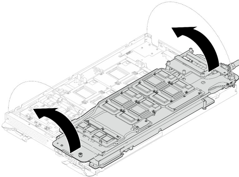
図 404. GPU ノードにウォーター・ループを広げる
