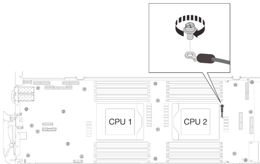
図 284. 遮蔽ケーブル 4 の取り付け
