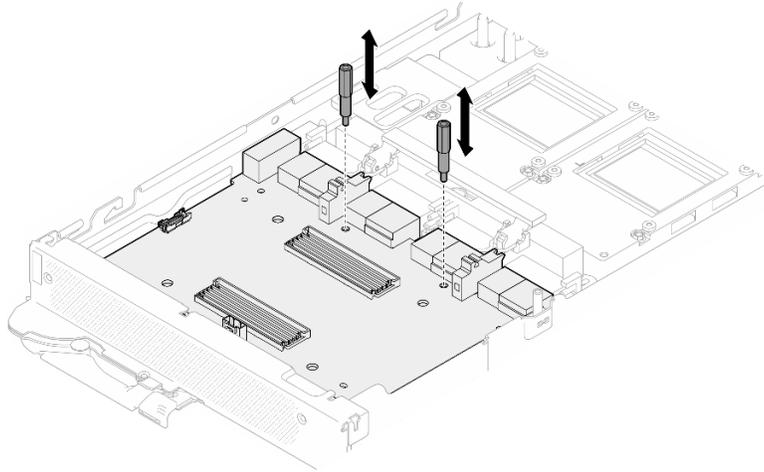
図 353. キャリア・ボードのスタンドオフの取り外し
