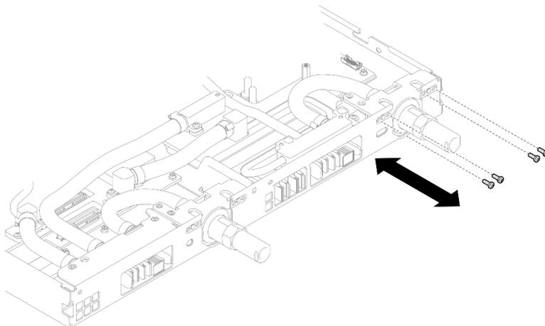
図 348. クイック・コネクットのねじの取り付け (GPU ノード)
