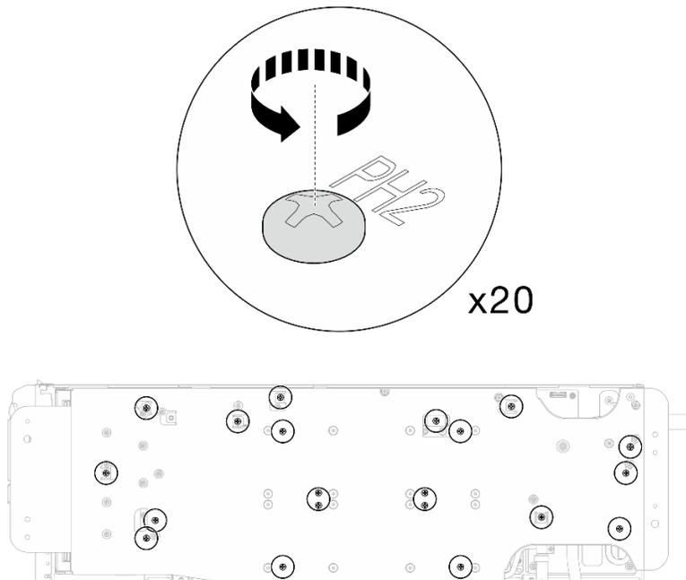
図 344. ウォーター・ループのねじとクイック・コネクットのねじの取り付け (GPU ノード)
