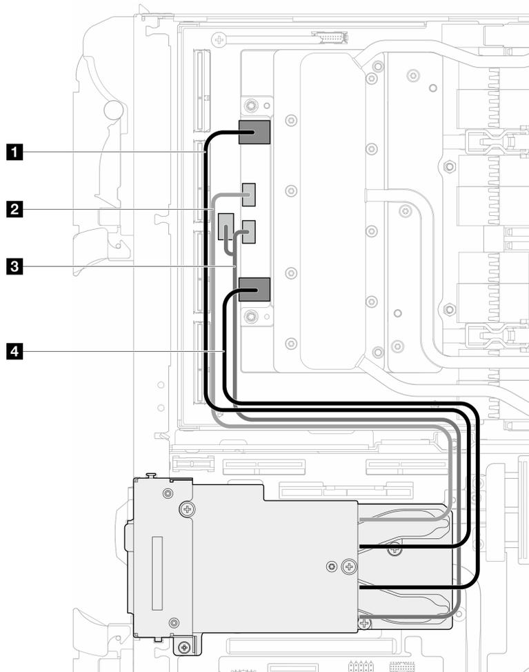
図 414. ネットワーク・ボードから OSFP モジュール・ケーブルを取り外す
