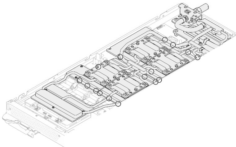
図 19. GPU コールド・プレートを取り外すための切り欠き
