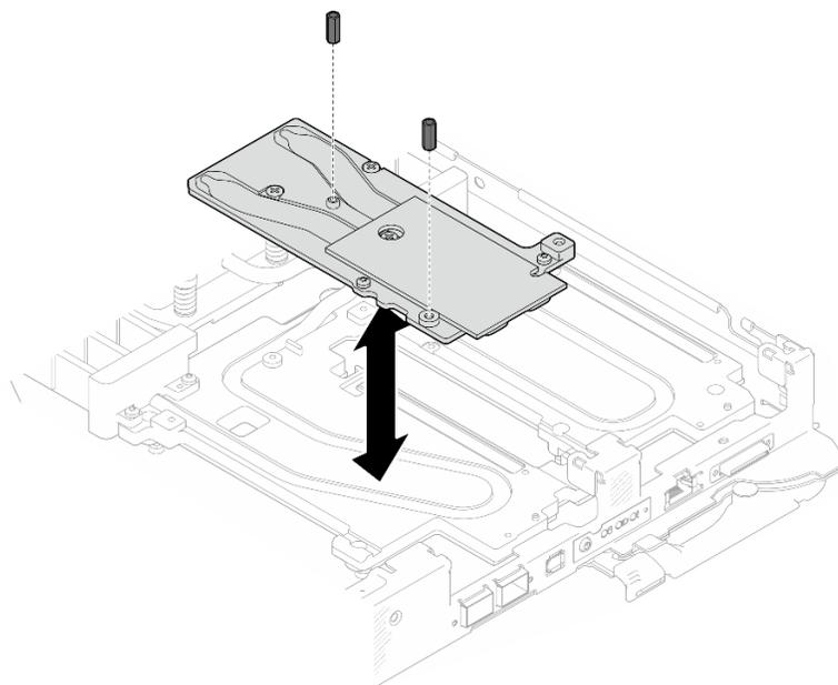
図 182. OSFP モジュール 伝導プレートの六角ねじの取り外し
