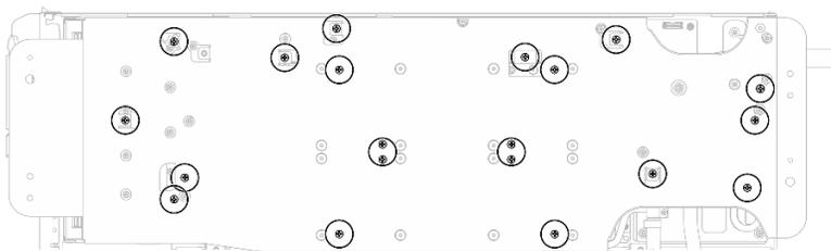
図 405. ウォーター・ループのねじとクイック・コネクットのねじの取り付け (GPU ノード)
