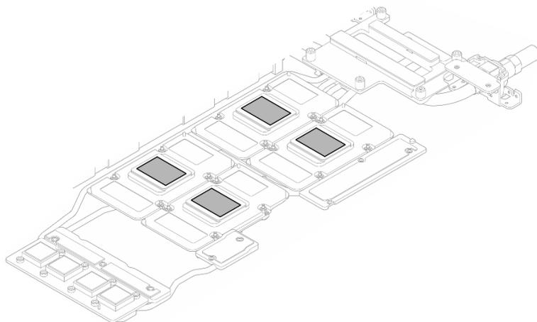
図 334. すべての GPU からの PCM のクリーニング
