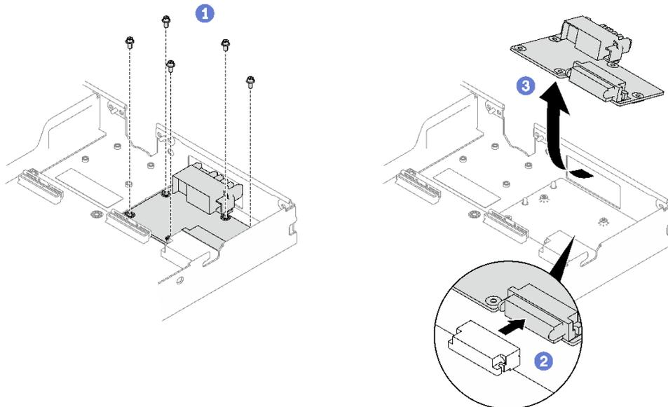
図 193. 分電盤の取り外し
