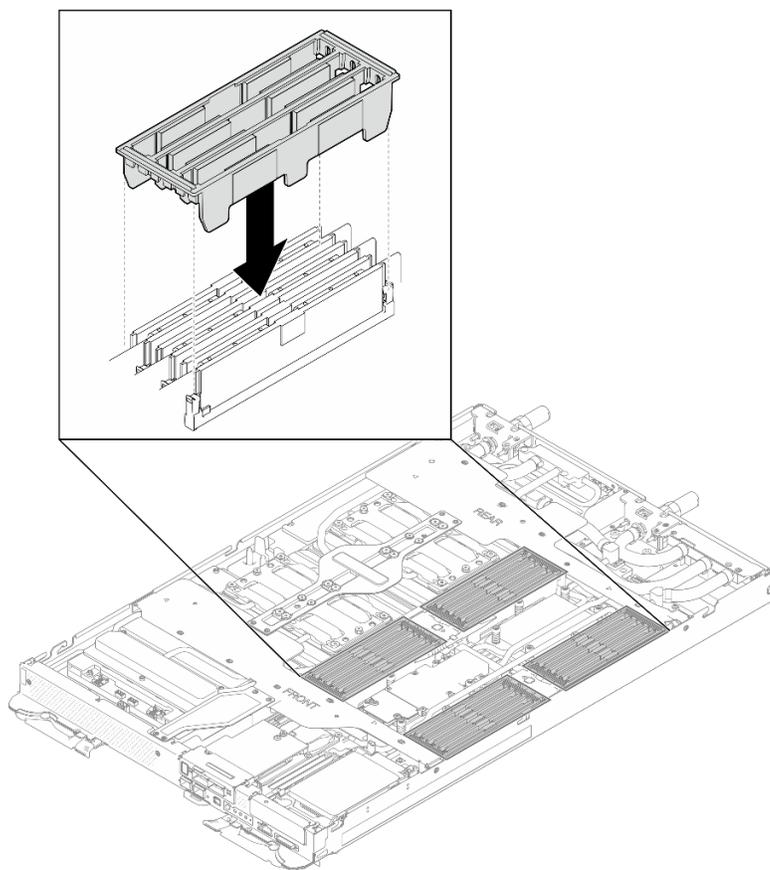
図 164. DIMM カバーの取り付け
