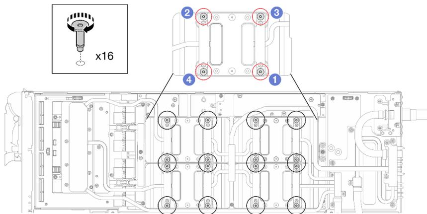
図440. GPU コールド・プレートのねじの取り付け
