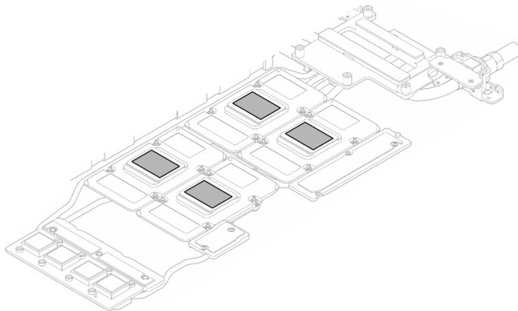
図 24. すべての GPU からの PCM のクリーニング
