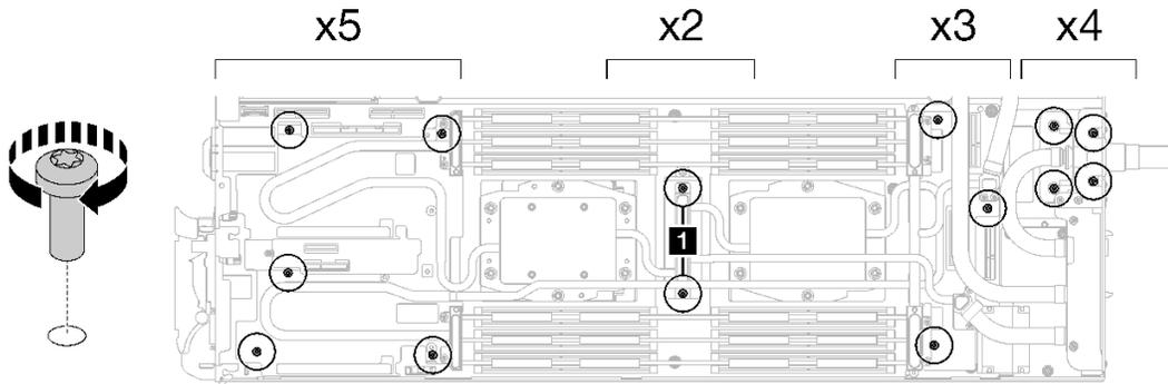
図 236. ウォーター・ループのねじとクイック・コネクットのねじの取り付け
