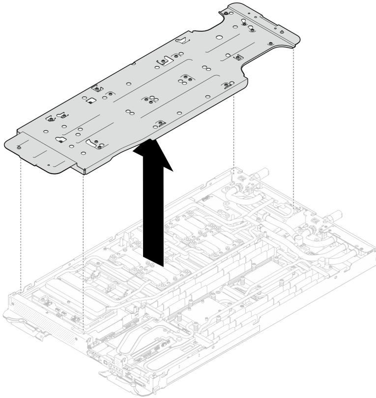
図 439. ウォーター・ループ・キャリアの取り外し (GPU ノード)
