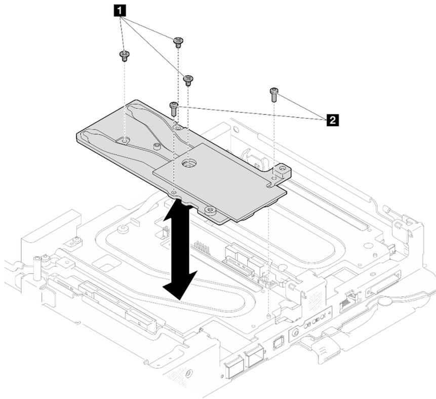
図 242. OSFP モジュール 伝導プレートの取り外し
