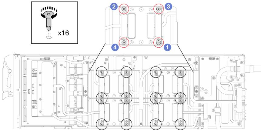
図 346. GPU コールド・プレートのねじの取り付け
