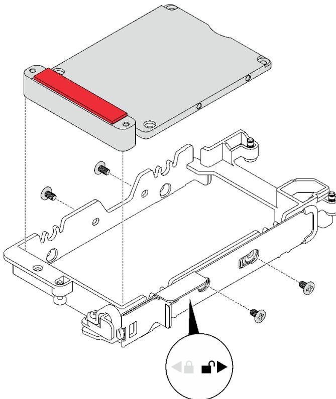
図94. 導電プレートの取り外し
