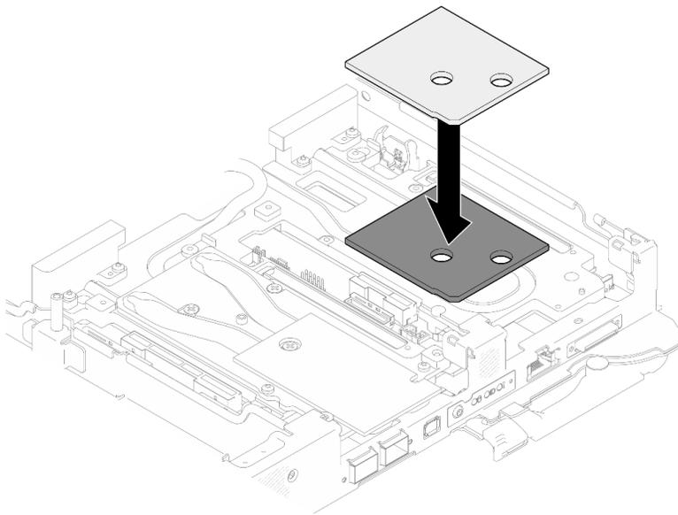
図118. ギャップ・パッドの交換
