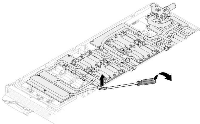
図 390. GPU からの GPU コールド・プレートの取り外し
