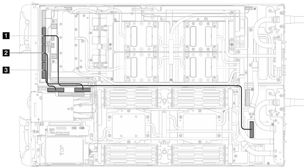
図 169. 2 プロセッサ構成 - MCIO 2、MCIO 3、および MCIO 4 ケーブルを取り外す
