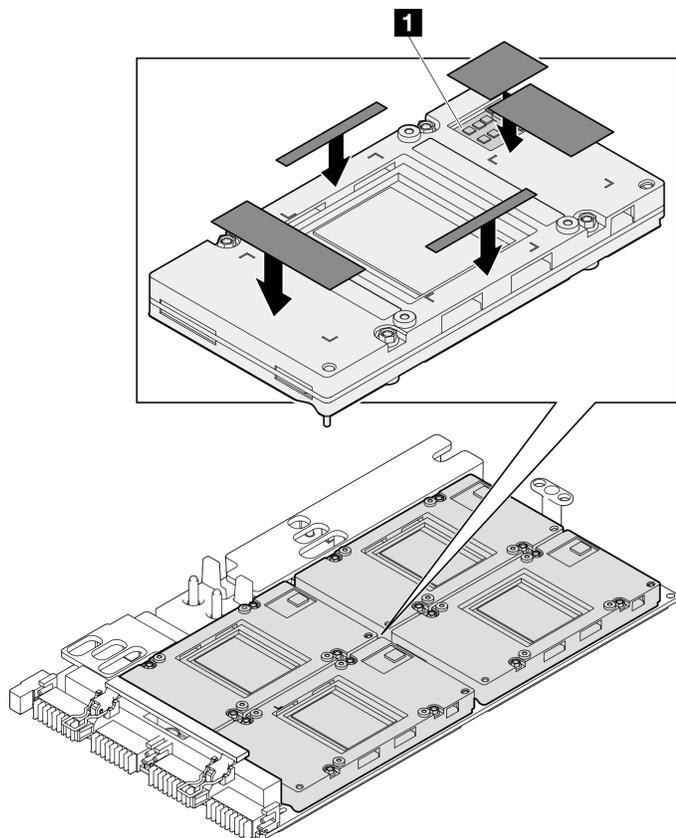
図 48. GPU パテ・パッドの交換
