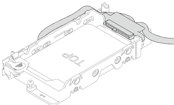
図 96. 接続していないケーブル・プラグの固定
