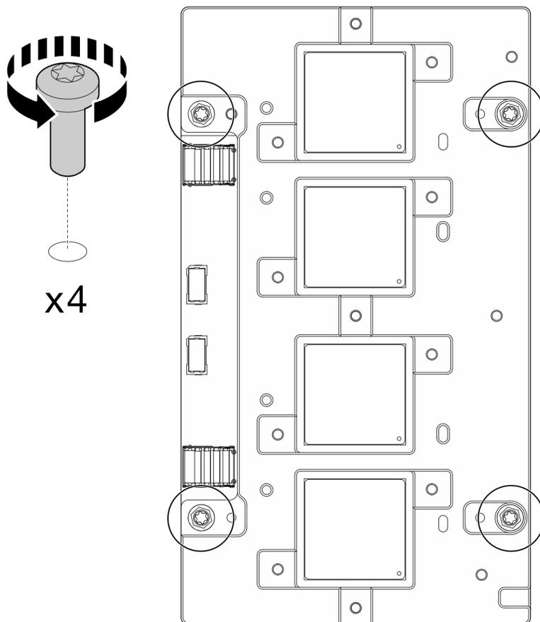
図 430. ネットワーク・ボードのねじの取り外し
