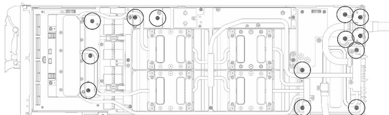
図 410. ウォーター・ループ Torx T10 ねじの取り付け (GPU ノード)
