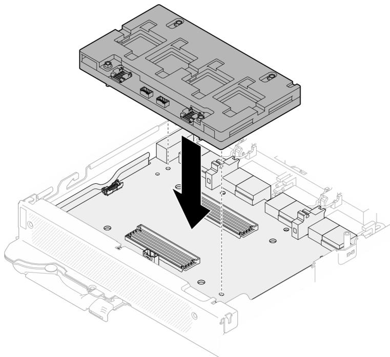
図432. ネットワーク・ボードの取り付け
