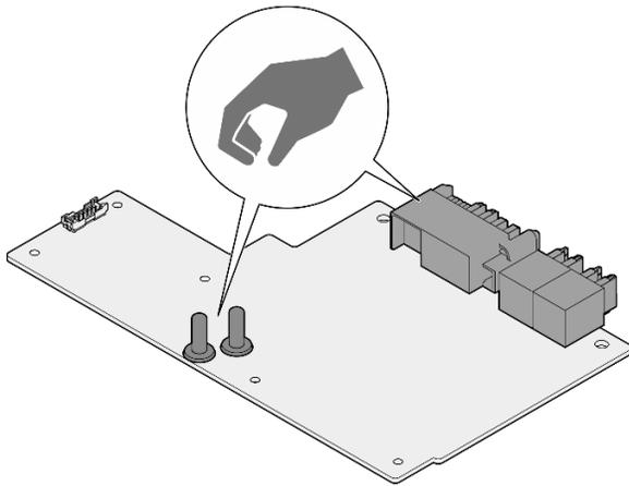
図 380. SD665-N V3 GPU 分電盤のタッチ・ポイント
