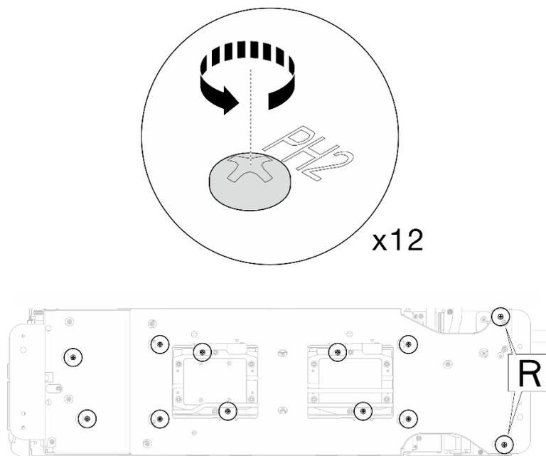
図35. ウォーター・ループ・キャリアねじの取り付け (計算ノード)
