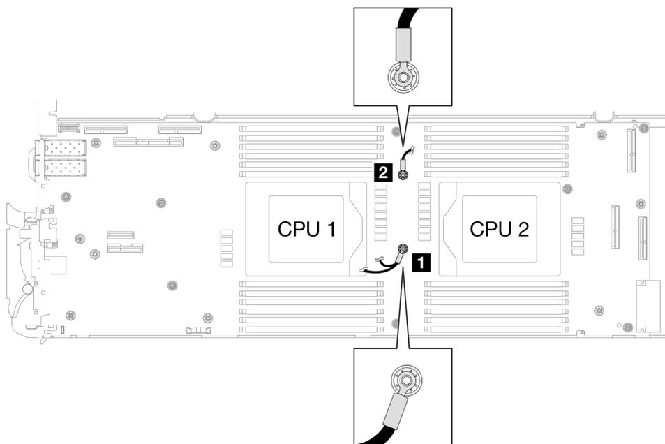
図 279. 遮蔽ケーブル 1/2 および遮蔽ケーブル 3 とねじ穴の位置合わせ
