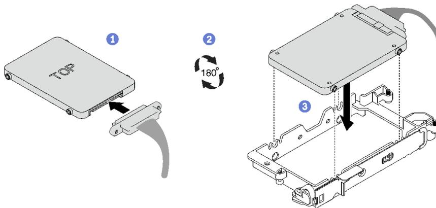
図 95. 7 mm ドライブの取り付け
