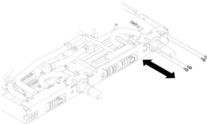
図15. クイック・コネクットのねじの取り外し (GPU ノード)
