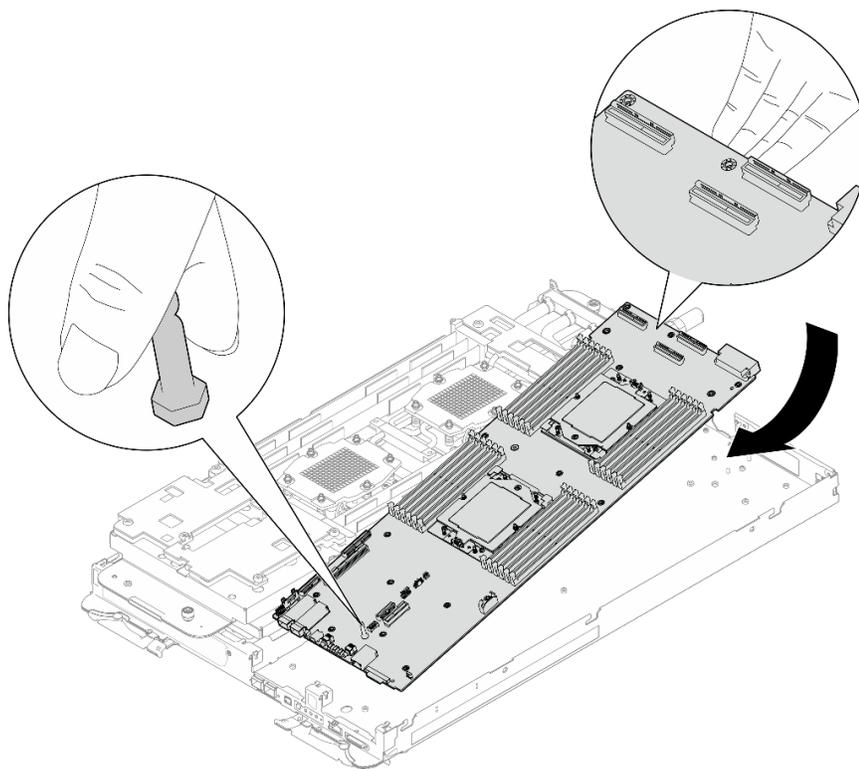
図276. システム・ボードの取り付け
