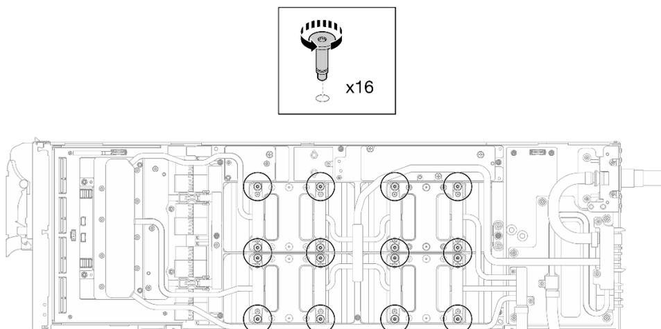
図 17. GPU コールド・プレートねじを緩める
