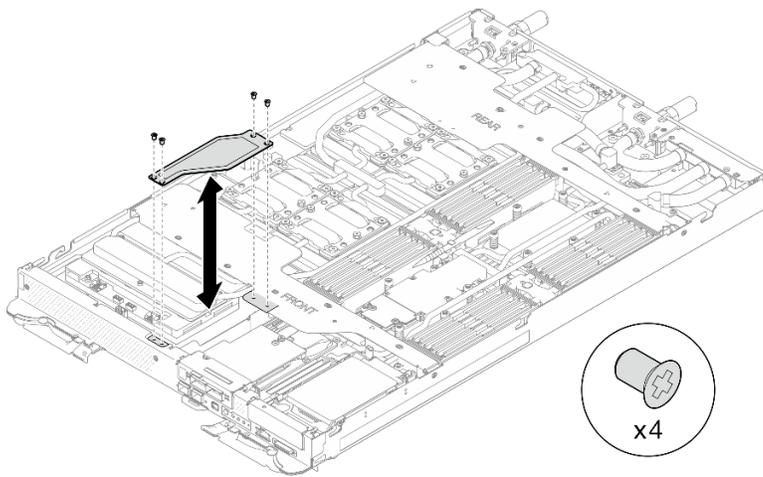
図7. 前面ケーブル・カバーの取り外し
