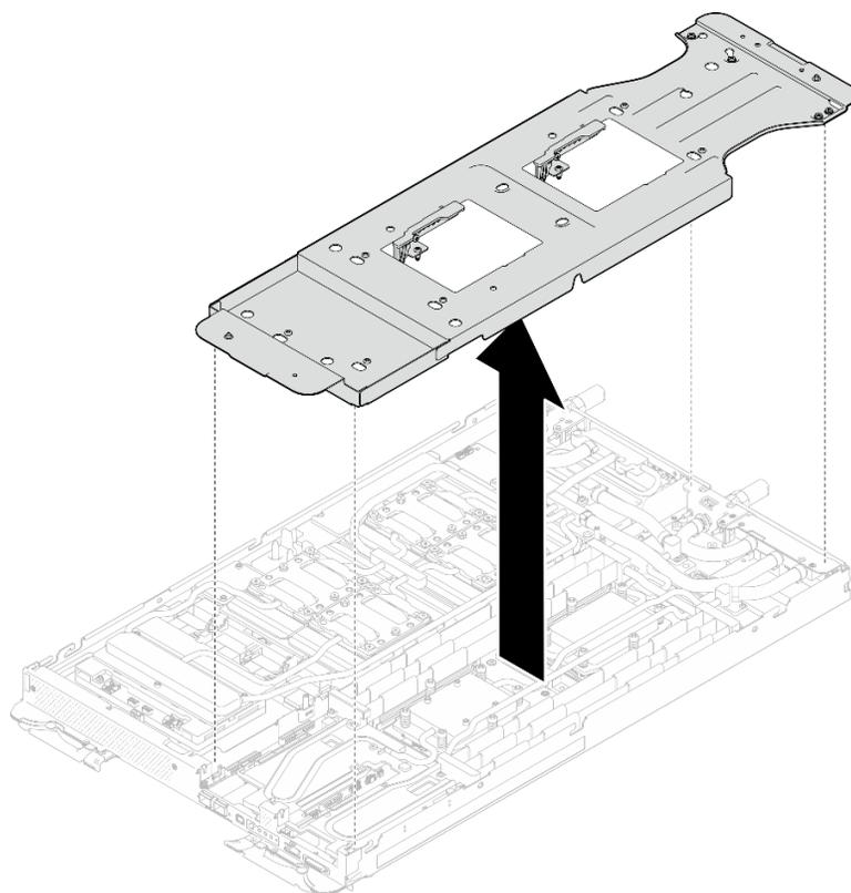
図202. ウォーター・ループ・キャリアの取り外し (計算ノード)
