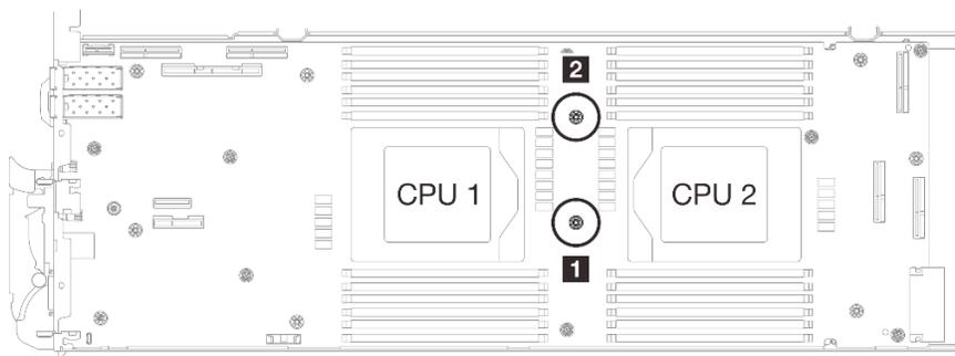
図71. 遮蔽ケーブル 1/2 および 3 のねじ穴の位置
