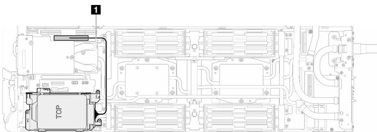
図 180. ドライブ・ケーブルの接続
