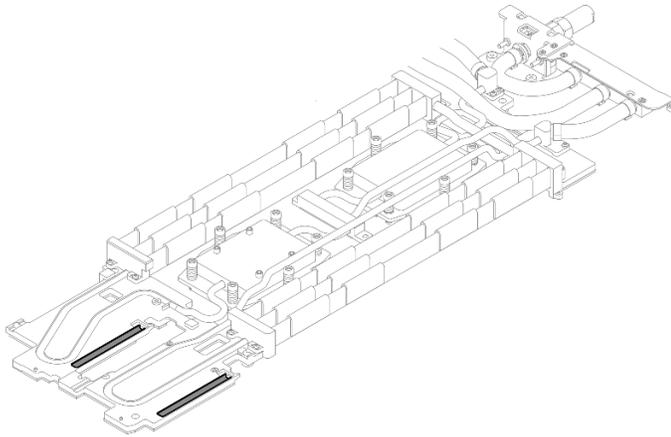
図45. ウォーター・ループ上面のギャップ・パッド (計算ノード側)
