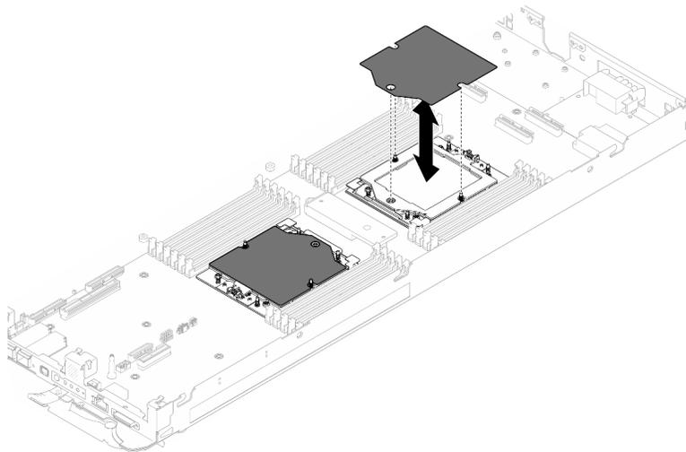
図253. プロセッサ・ソケット保護フィルムの取り付け
