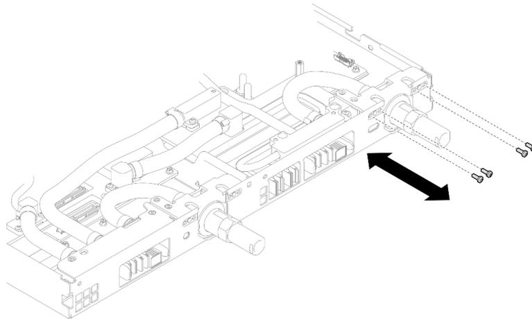
図 409. クイック・コネクットのねじの取り付け (GPU ノード)
