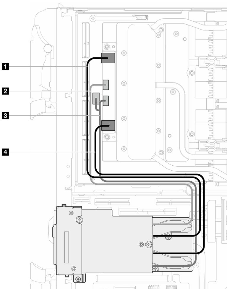
図 170. ネットワーク・ボードから OSFP モジュール・ケーブルを取り外す
