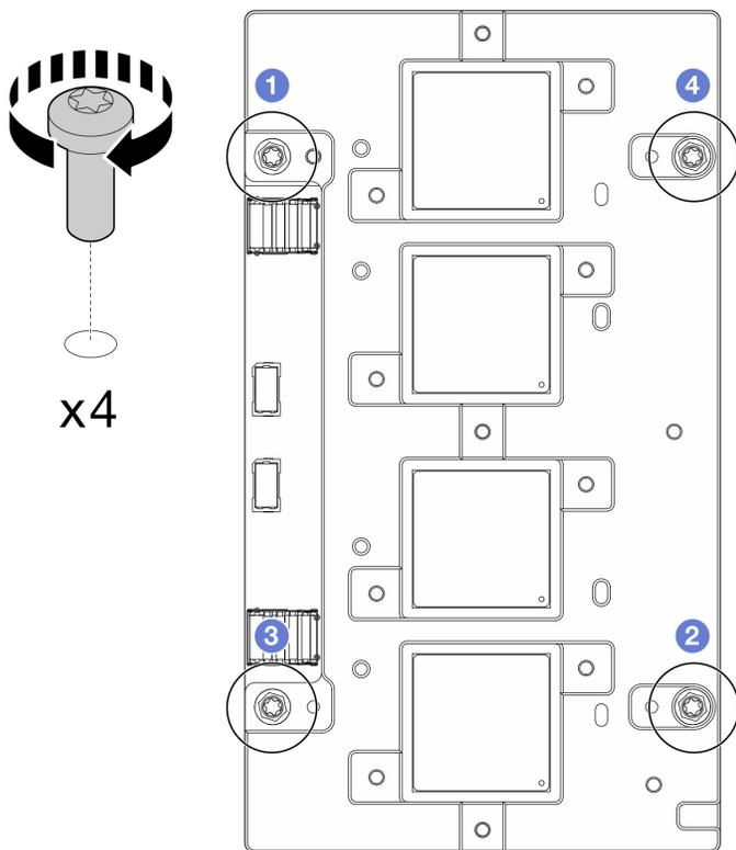
図 433. ネットワーク・ボードのねじの取り付け
