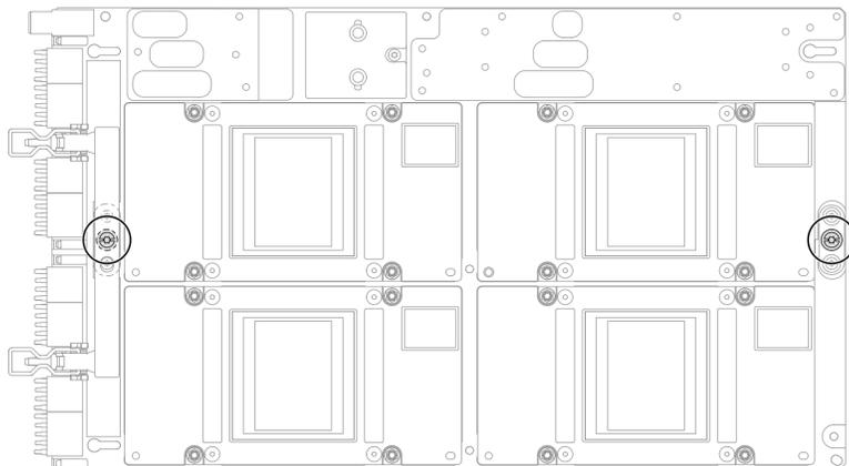
図 371. GPU ボード・アセンブリーの T15 ねじの取り外し
