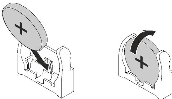
図 82. CMOS バッテリーの取り付け
