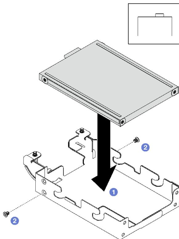
図 130. 上部 E3.s ドライブの取り付け
