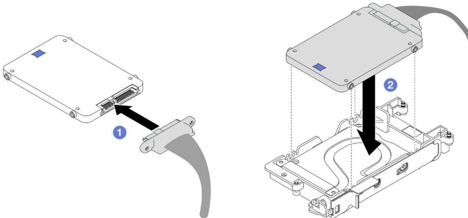
図 114. 下段ドライブの取り付け
