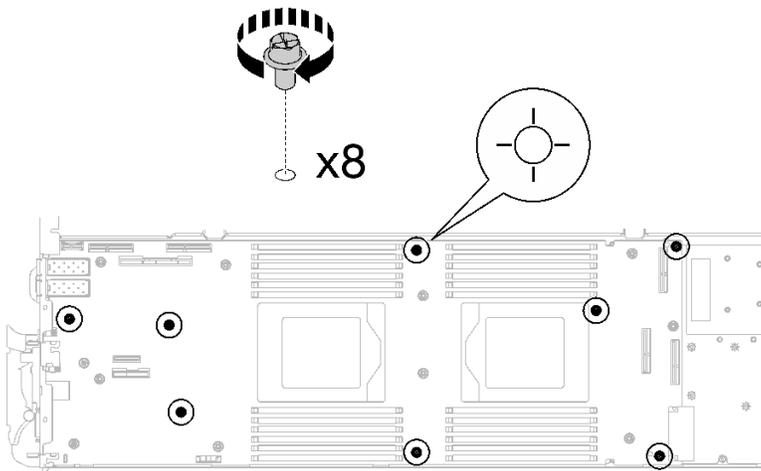
図 307. システム・ボードのねじの取り付け
