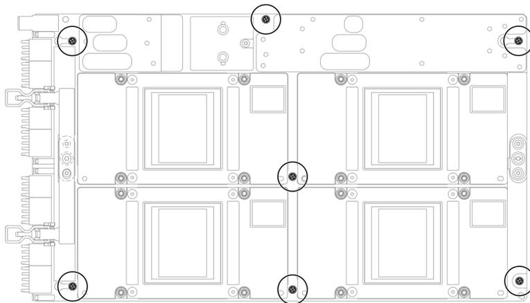
図375. GPU ボード・アセンブリーへの M3 ねじの取り付け
