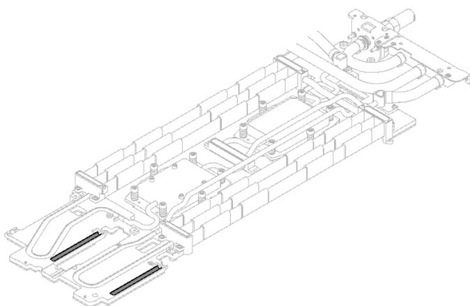
図 257. ウォーター・ループ・ギャップ・パッド (上面)
