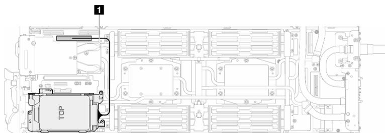
図 87. ドライブ・ケーブルの取り外し
