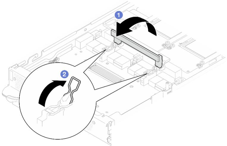
図 368. キャリア・ボードの取り外し
