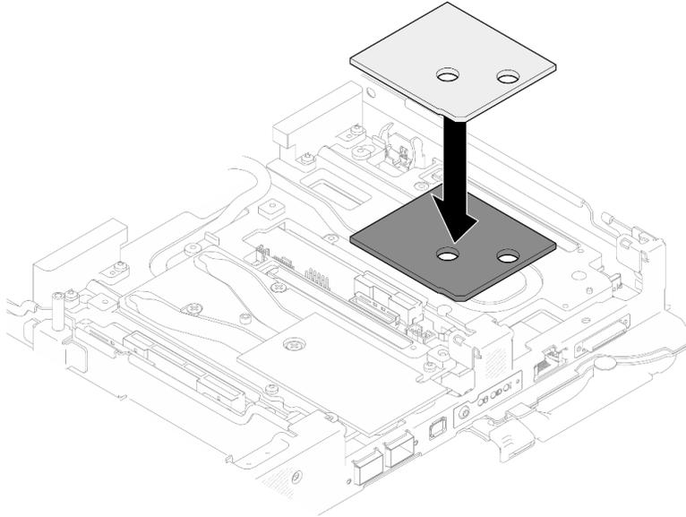
図 103. ギャップ・パッドの交換
