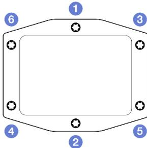
図 32. プロセッサ・コールド・プレート・ラベル
