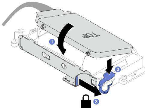
図 99. 上段ドライブの取り付け (7mm ドライブ)
