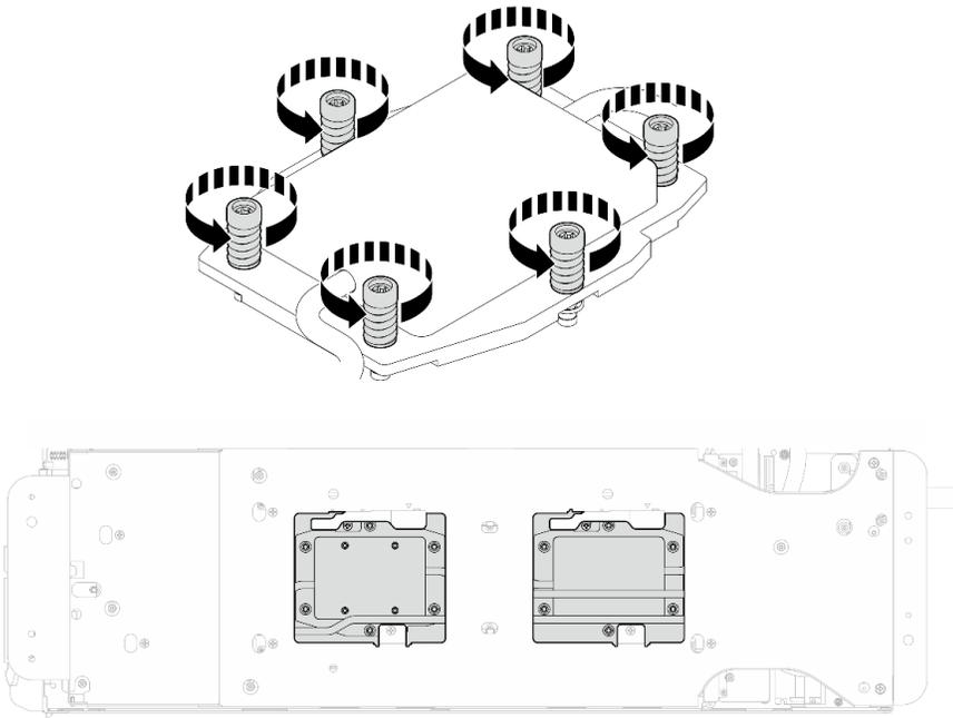
図188. プロセッサ・コールド・プレートの取り外し
