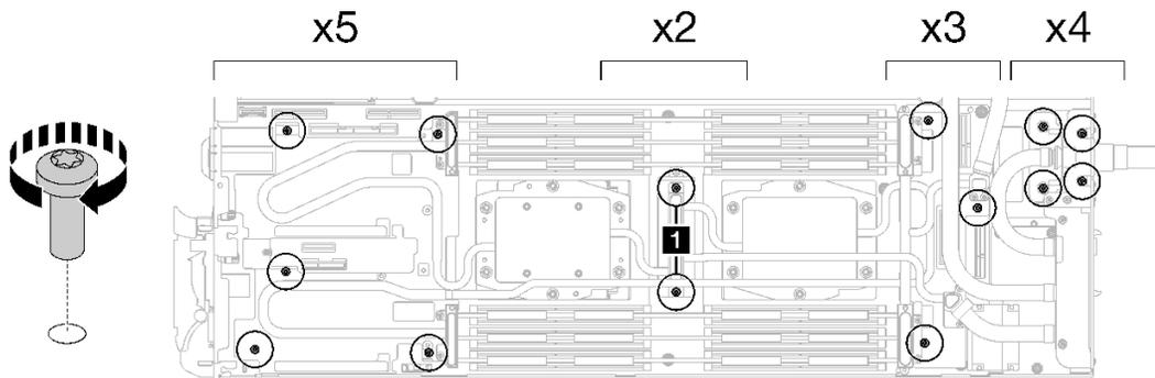
図 205. ウォーター・ループのねじとクイック・コネクットのねじの取り付け
