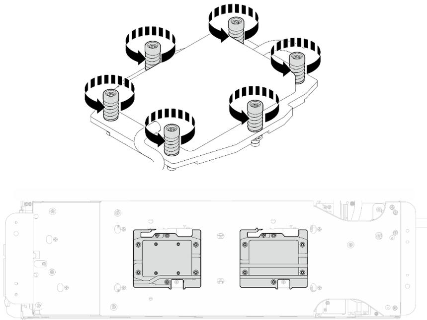
図33. プロセッサ・コールド・プレートの取り外し
