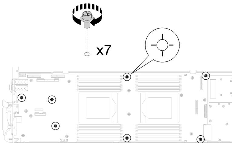
図 303. システム・ボードのねじの取り付け
