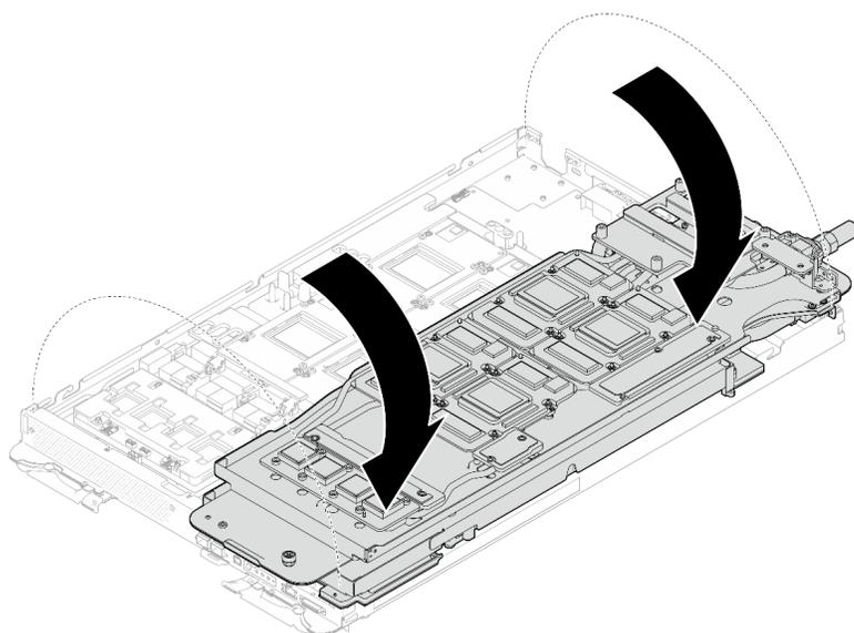
図 427. GPU ノード側のウォーター・ループを計算ノード側のウォーター・ループに折りたたむ
