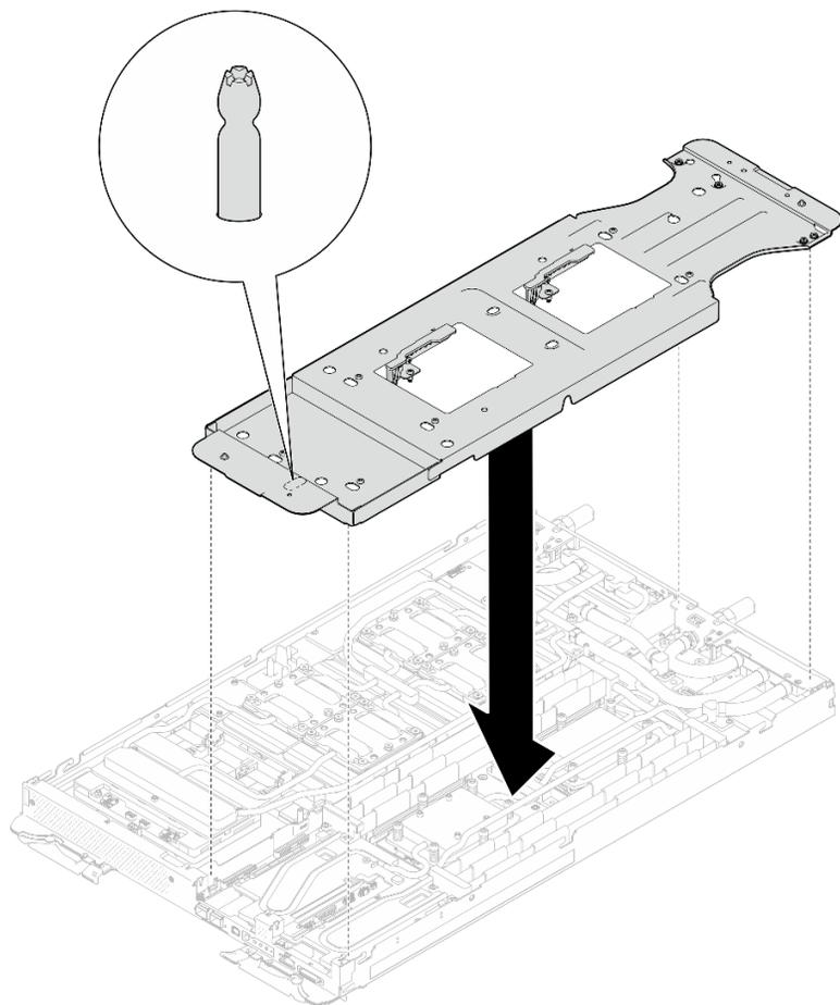
図189. ウォーター・ループ・キャリアの取り付け (計算ノード)
