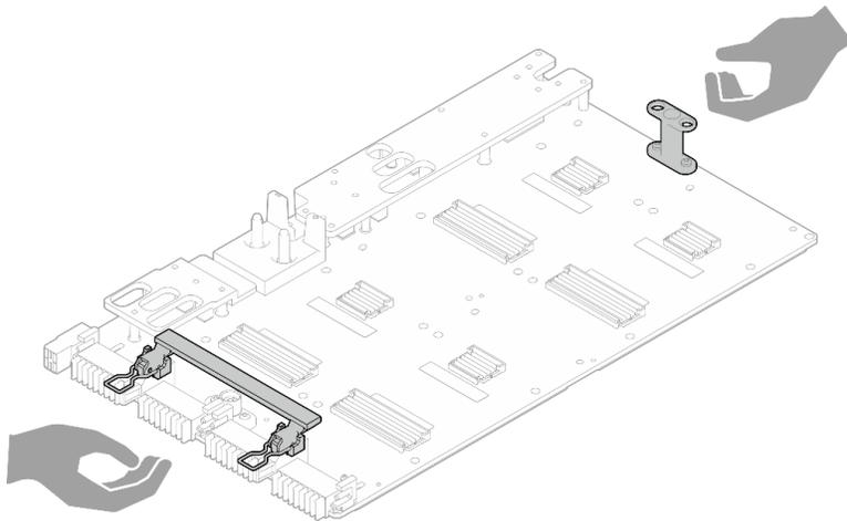
図 360. パッケージ・ボックスからの GPU ボードの取り出し
