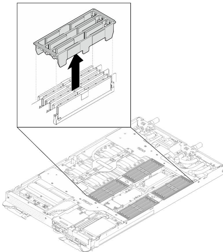
図 154. DIMM カバーの取り外し
