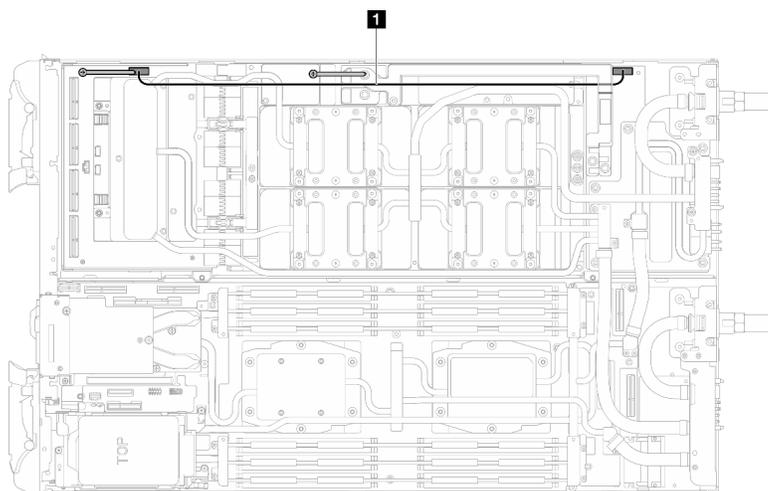
図 312. キャリア・ボードの電源ケーブルの取り外し
