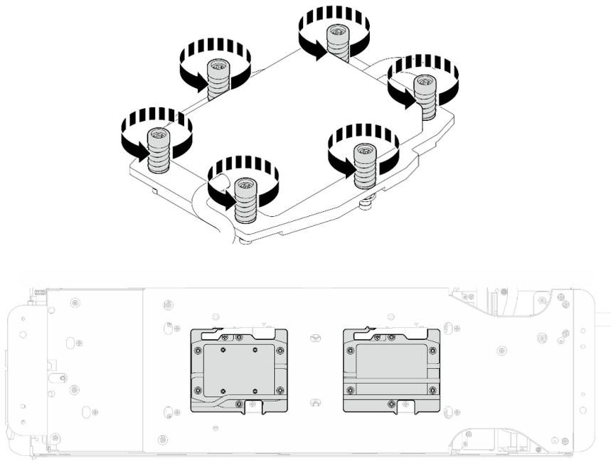
図217. プロセッサ・コールド・プレートの取り外し
