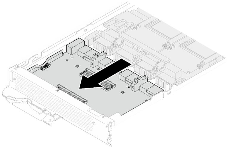
図 355. GPU ボードからのキャリア・ボードの取り外し
