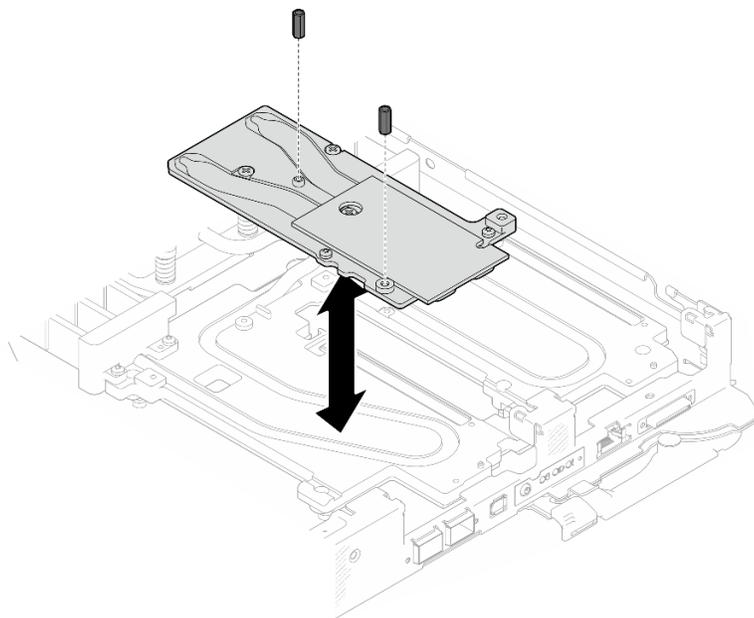
図59. OSFP モジュール 伝導プレートの六角ねじの取り付け
