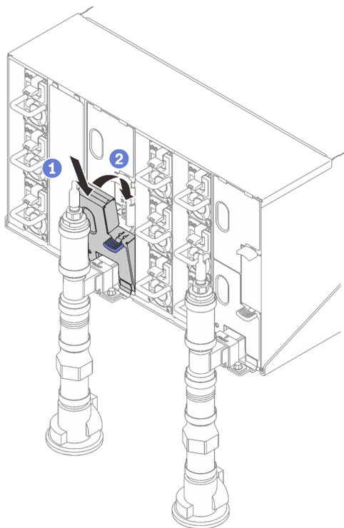
図 468. 下段 EMC シールドの取り付け
