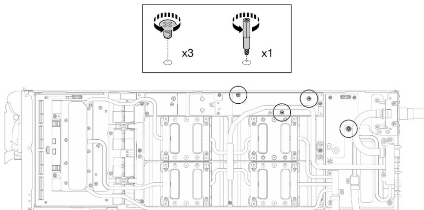
図417. ウォーター・ループ六角ねじおよびPH1 ねじの取り外し (GPU ノード)
