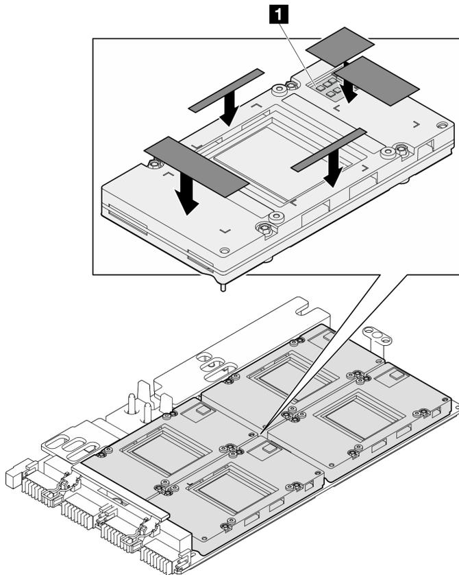
図342. GPUパテ・パッドの交換
