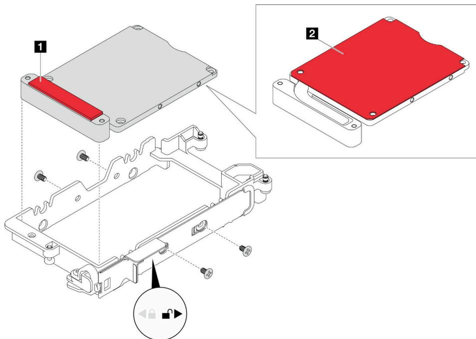
図97. 導電プレートの取り付け
