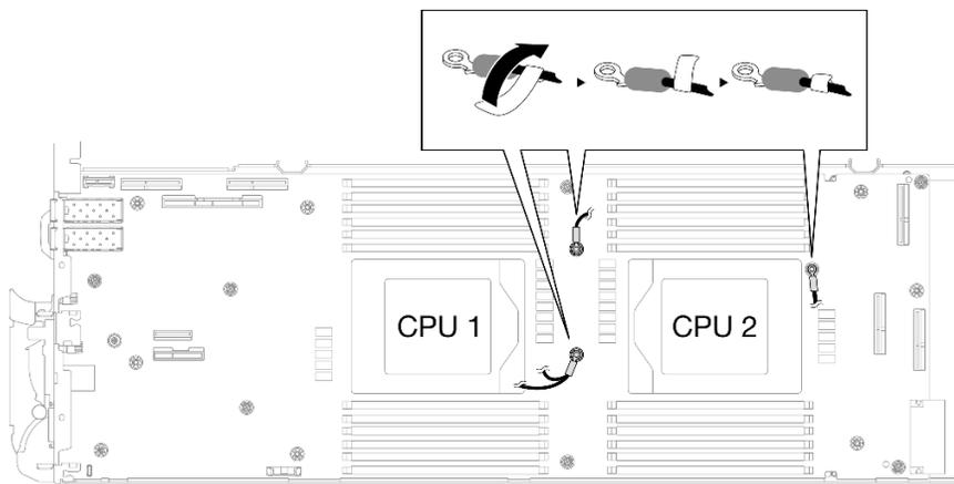
図 302. 遮蔽ケーブルへのラベルの巻き付け
