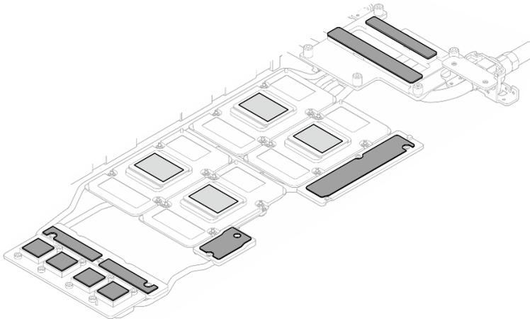
図 341. ウォーター・ループのパテ・パッドの交換 (GPU ノード)
