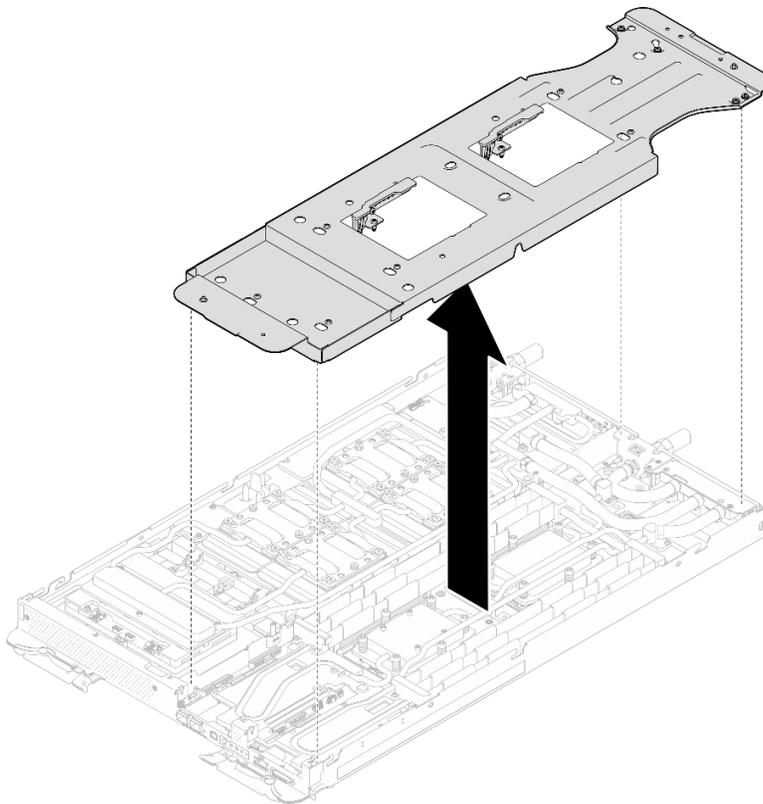
図 233. ウォーター・ループ・キャリアの取り外し (計算ノード)
