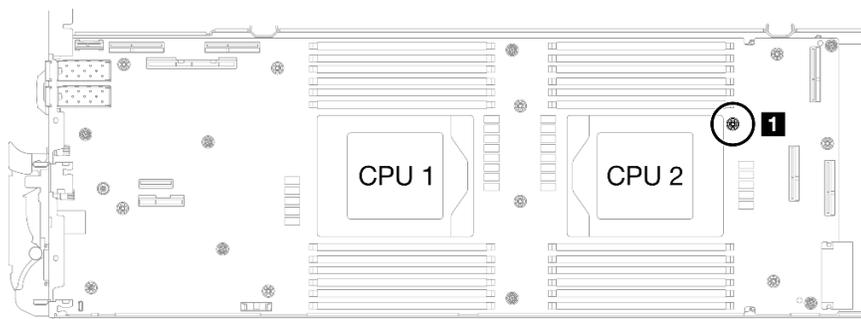
図 283. 遮蔽ケーブル 4 のねじ穴の位置
