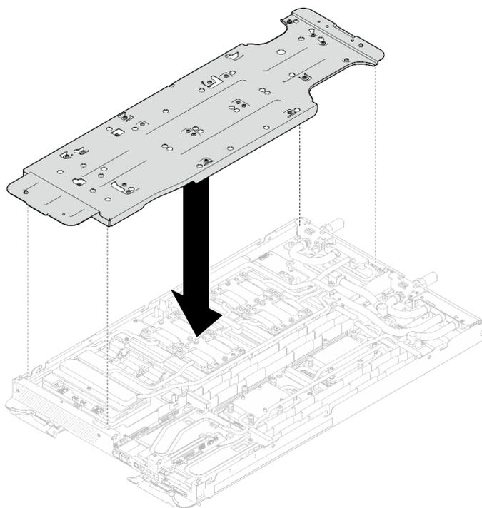
図 391. ウォーター・ループ・キャリアの取り付け (GPU ノード)
