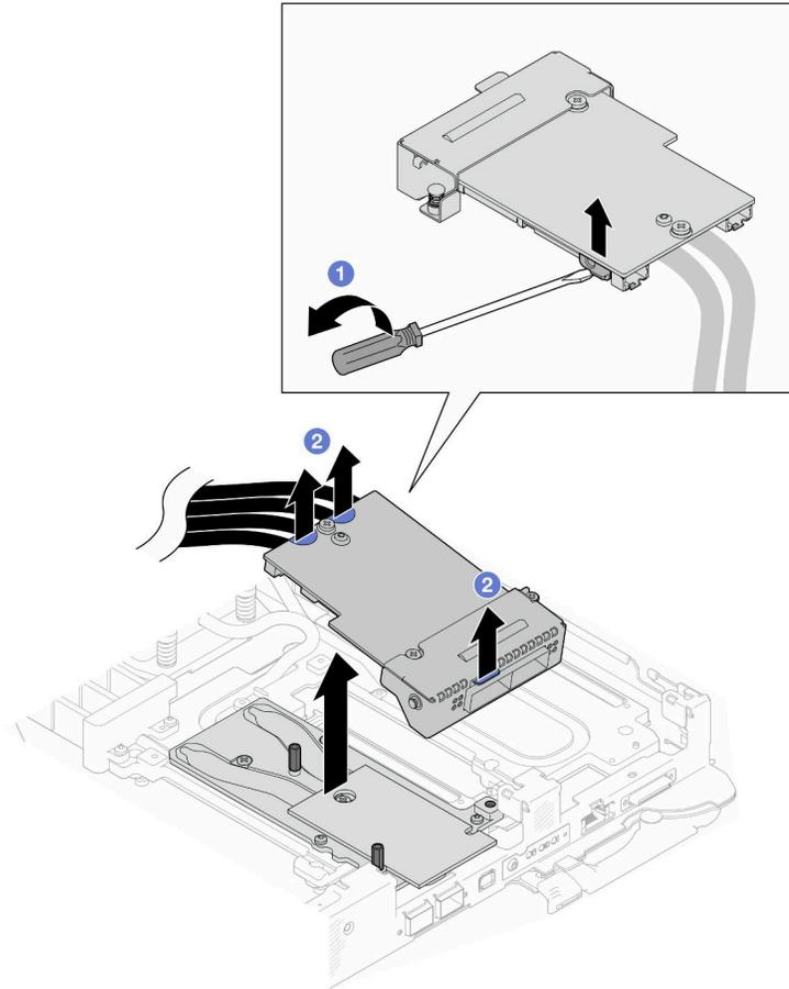
図 172. OSFP モジュールの取り外し
