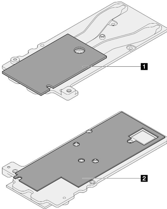
図57. OSFP モジュールの伝導プレートのパテ・パッドの交換
