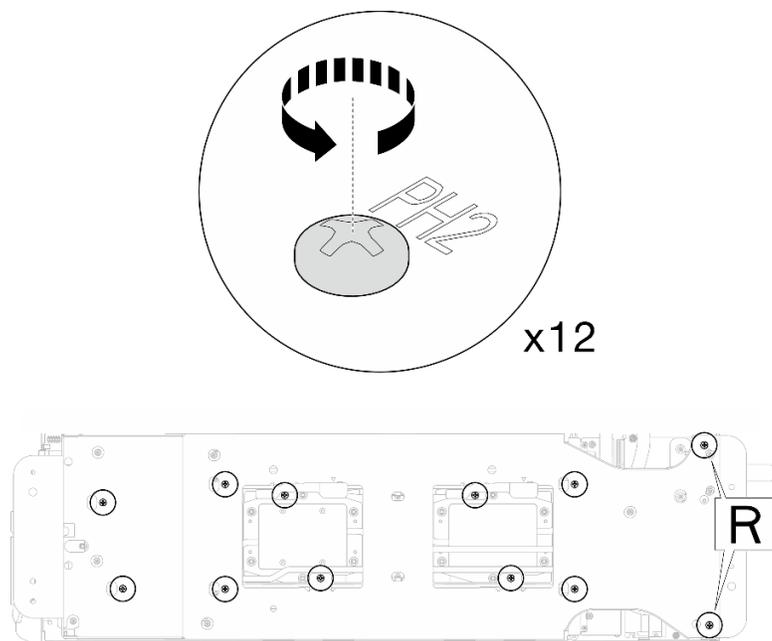
図 190. ウォーター・ループ・キャリアねじの取り付け (計算ノード)
