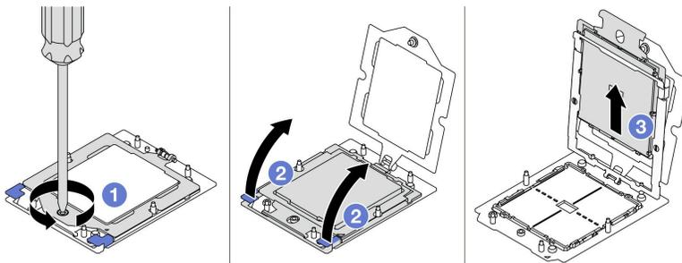
図222. プロセッサの取り外し
