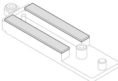
図 70. VR 伝導プレートの底面にあるパテ・パッド
