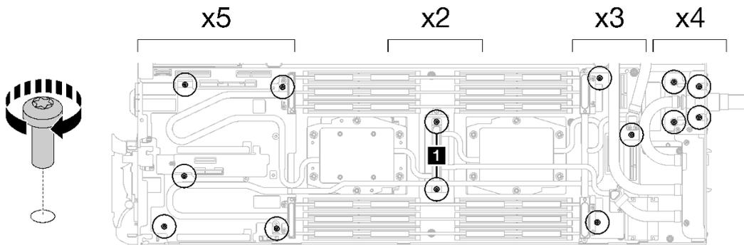
図 55. ウォーター・ループのねじとクイック・コネクットのねじの取り付け
