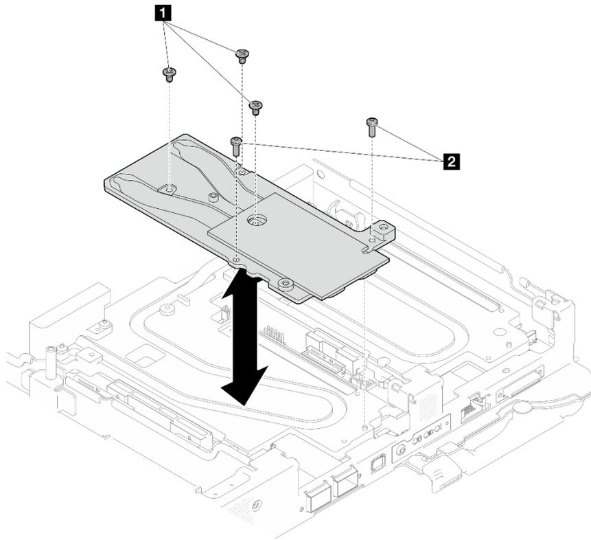
図 183. OSFP モジュール 伝導プレートの取り外し
