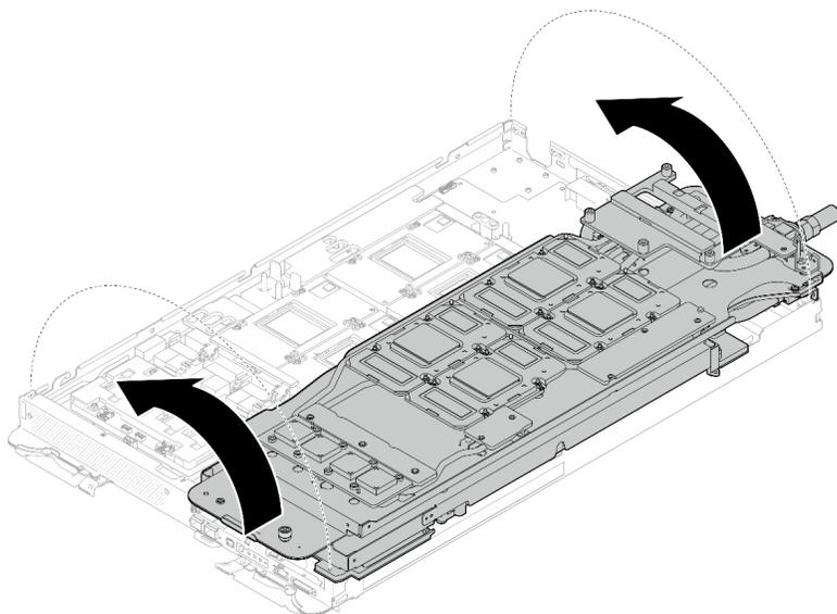
図26. GPU ノードのウォーター・ループを裏返して GPU ノードに取り付け直す
