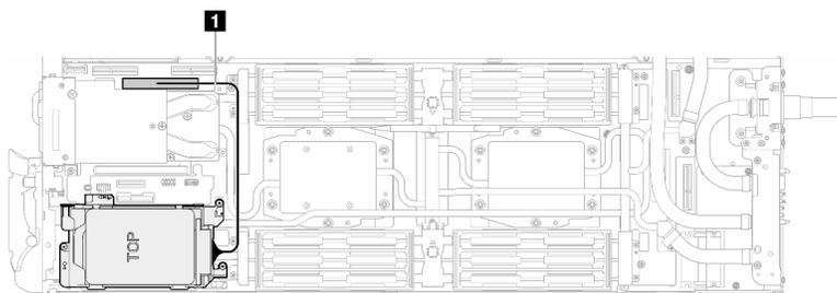
図 166. ドライブ・ケーブルの取り外し
