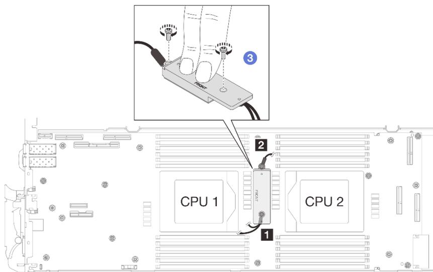
図 299. 遮蔽ケーブル 1/2 および 3 の取り付け
