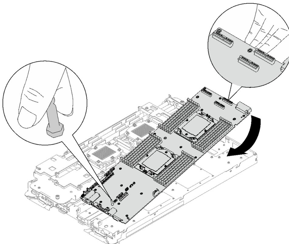
図296. システム・ボードの取り付け
