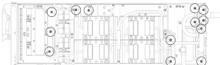
図 349. ウォーター・ループ Torx T10 ねじの取り付け (GPU ノード)
