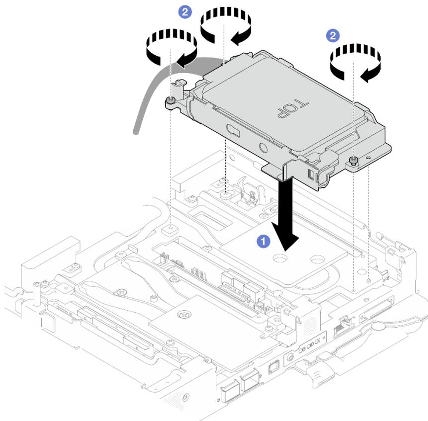
図 105. 2 個の 7 mm ドライブ・ケージ・アセンブリーの取り付け
