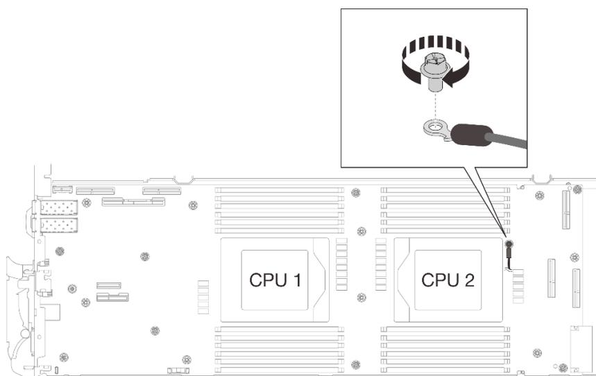
図 301. 遮蔽ケーブル 4 の取り付け
