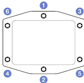
図 187. プロセッサ・コールド・プレート・ラベル
