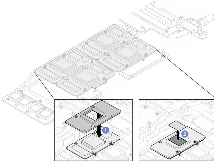
図 340. ウォーター・ループ GPU コールド・プレート PCM の交換 (GPU ノード)
