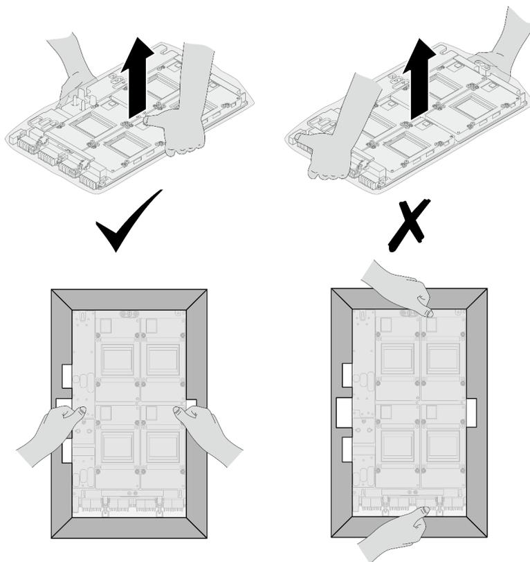
図372. パッケージ・ボックスからの GPU ボード・アセンブリーの取り出し
