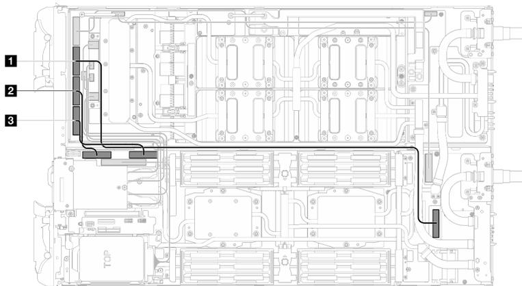
図 179. 2 プロセッサ構成 - MCIO 2、MCIO 3、および MCIO 4 ケーブルを GPU ノードに接続
