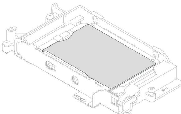
図 112. 導電プレートのギャップ・パッドの取り付け
