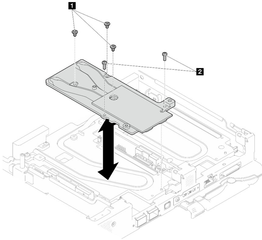
図 212. OSFP モジュール 伝導プレートの取り外し
