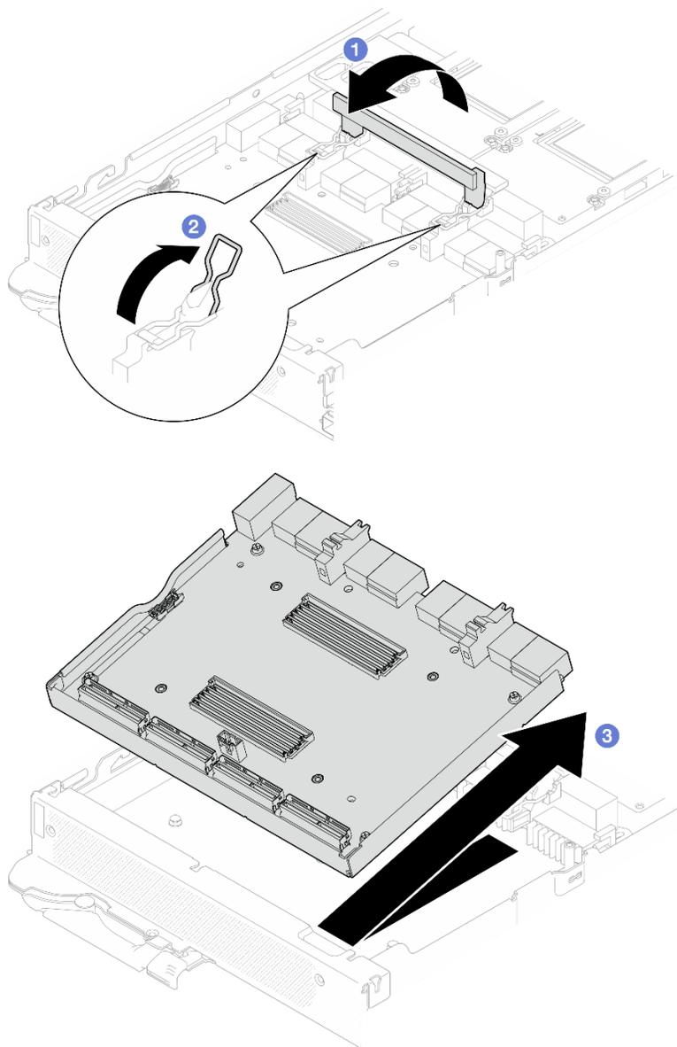
図314. キャリア・ボードの取り外し
