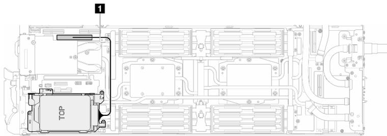
図 120. ドライブ・ケージ・ケーブルの接続
