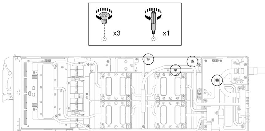
図 13. ウォーター・ループ六角ねじおよび PH1 ねじの取り外し (GPU ノード)
