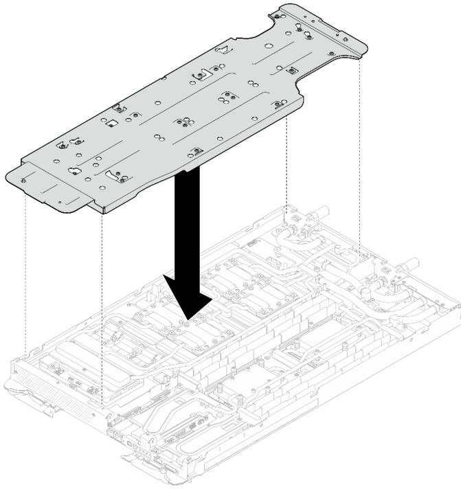
図 21. ウォーター・ループ・キャリアの取り付け (GPU ノード)
