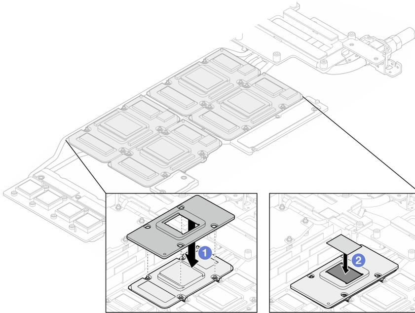
図 401. ウォーター・ループ GPU コールド・プレート PCM の交換 (GPU ノード)
