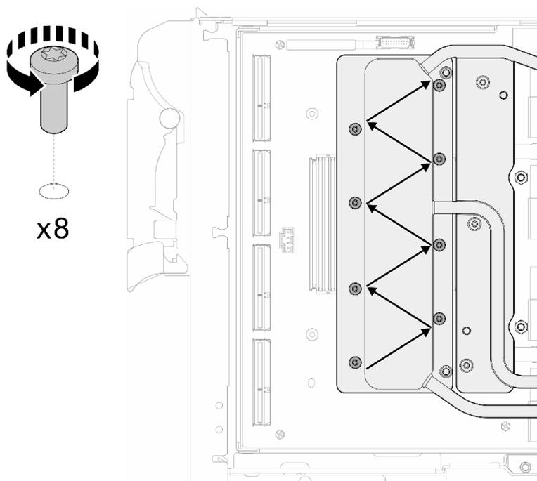
図420. ネットワーク・カードのねじの取り外し
