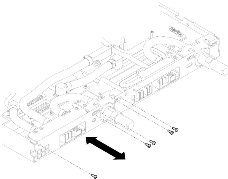
図29. クイック・コネクットのねじの取り外し (計算ノード)
