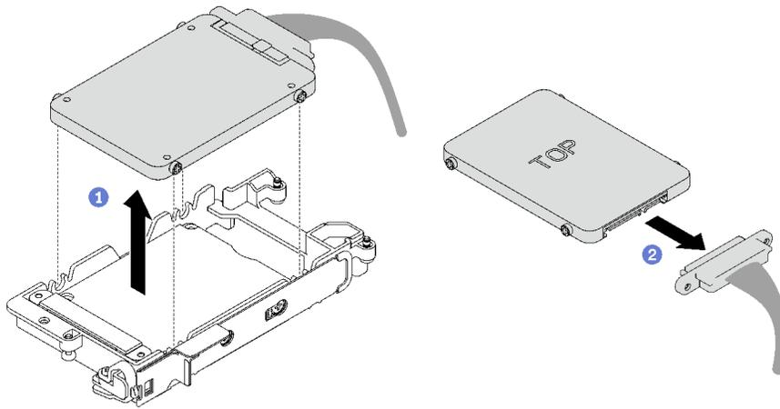
図93. 下段ドライブの取り外し
