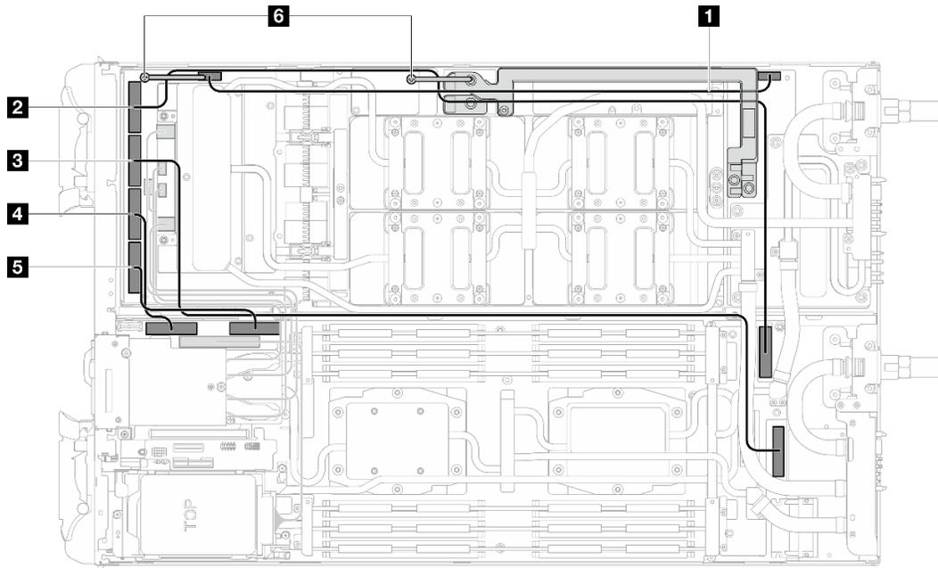
図 453. 2 プロセッサ構成のケーブル配線
