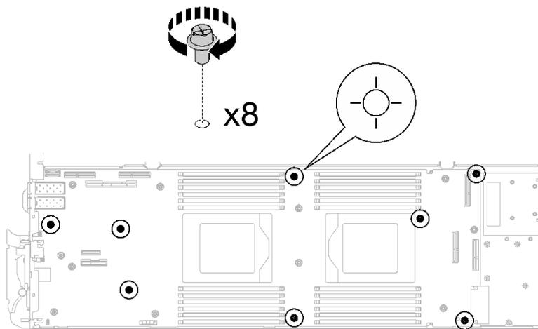
図272. システム・ボードのねじの取り外し
