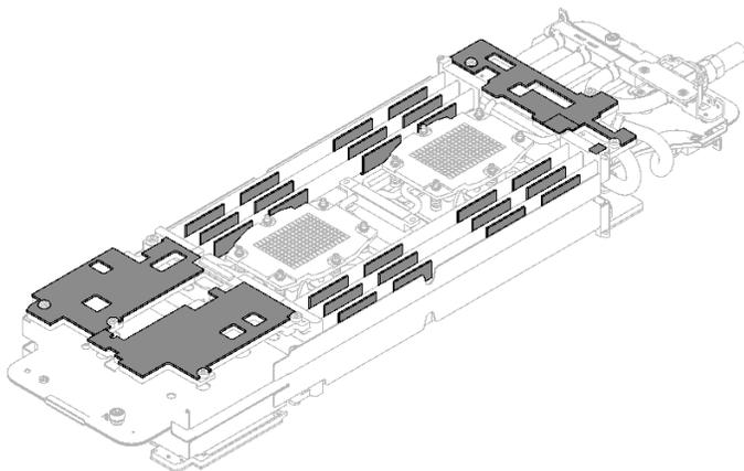
図 256. ウォーター・ループ・ギャップ・パッド (底面)
