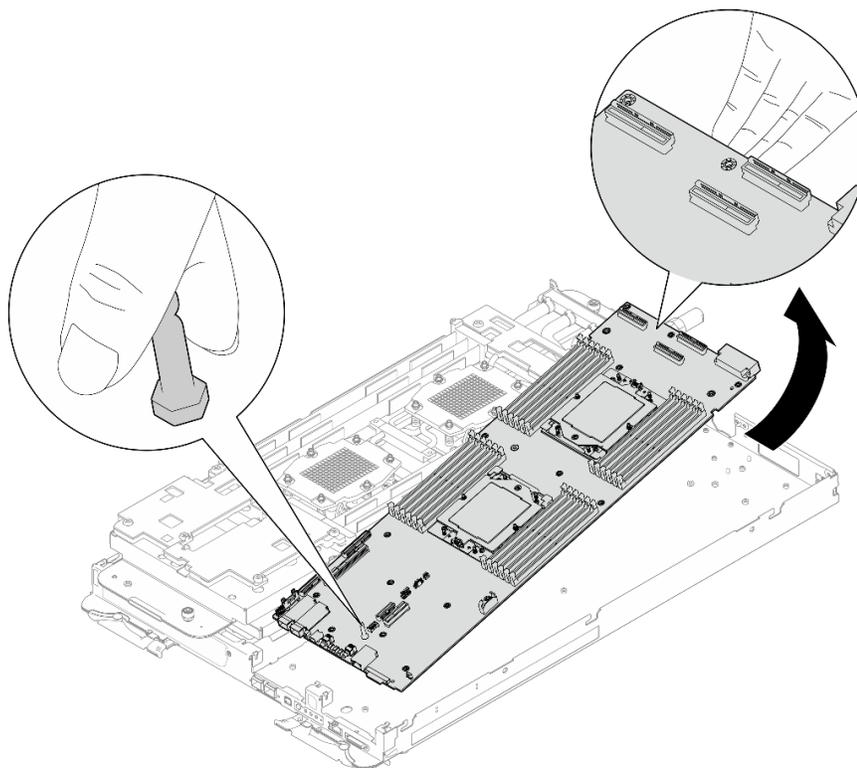
図273. システム・ボードの取り外し
