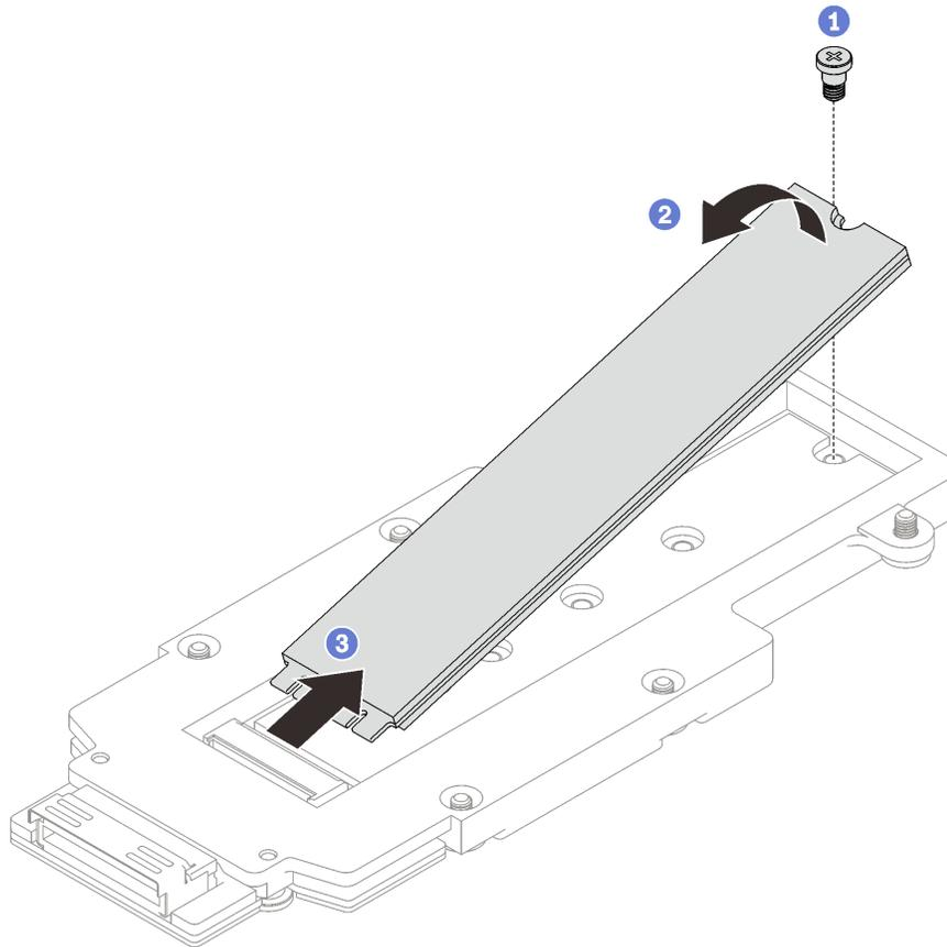
図 145. M.2 ドライブの取り外し
