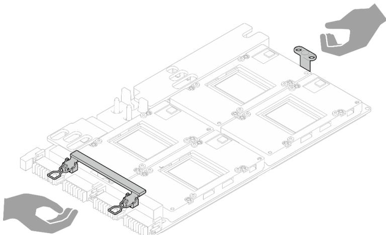
図 373. パッケージ・ボックスからの GPU ボード・アセンブリーの取り出し
