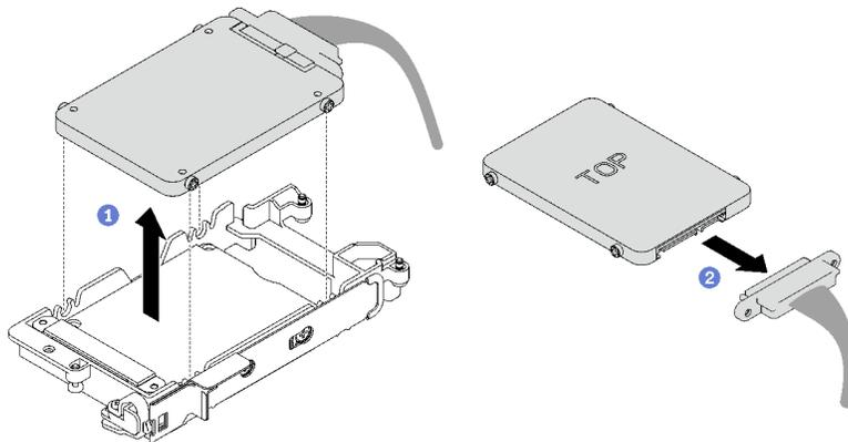
図91. 1台の7mmドライブの取り外し
