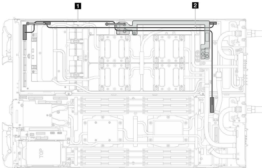
図 310. キャリア・ボード電源ケーブルおよび MCIO 1 ケーブルの配線
