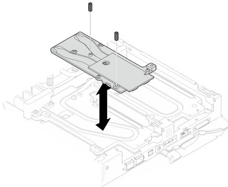
図27. OSFP モジュール 伝導プレートの六角ねじの取り外し
