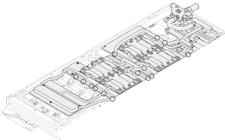
図 389. GPU コールド・プレートを取り外すための切り欠き
