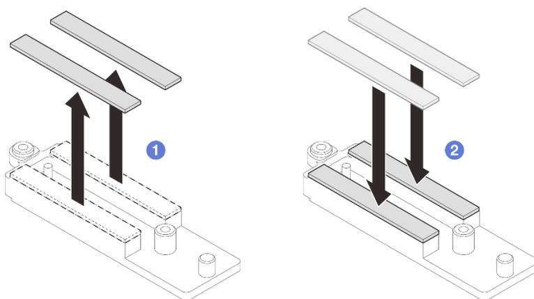
図 275. VR 伝導プレートのパテ・パッドの交換
