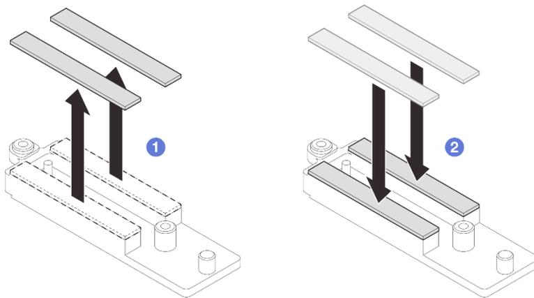
図295. VR伝導プレートのパテ・パッドの交換
