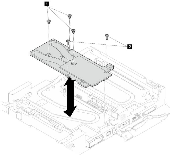
図 208. OSFP モジュール 伝導プレートの取り付け
