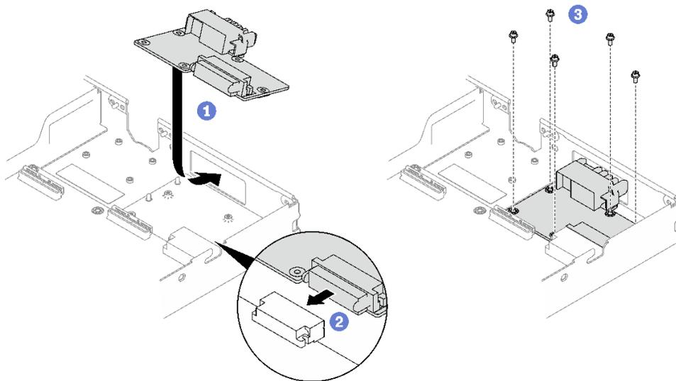
図 194. 分電盤の取り付け
