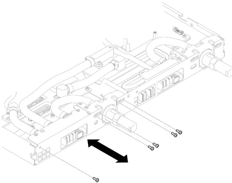
図 206. クイック・コネクットのねじの取り付け (計算ノード)
