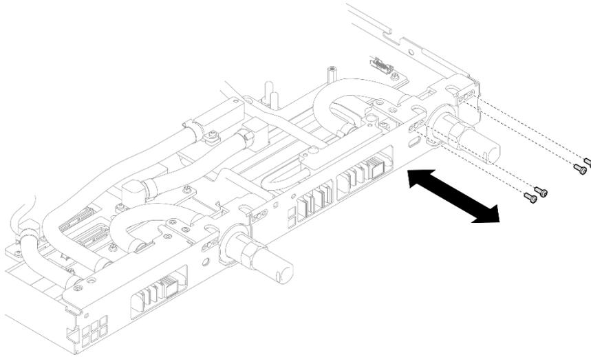
図325. クイック・コネクットのねじの取り外し (GPU ノード)
