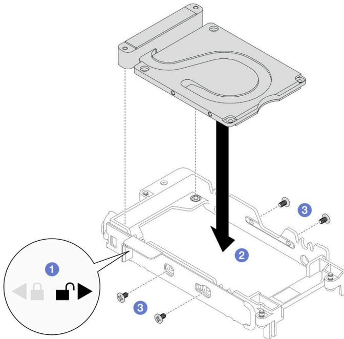
図 113. 導電プレートの取り付け
