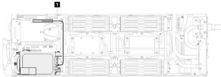
図 121. E3.S ドライブ・ケーブルの取り外し
