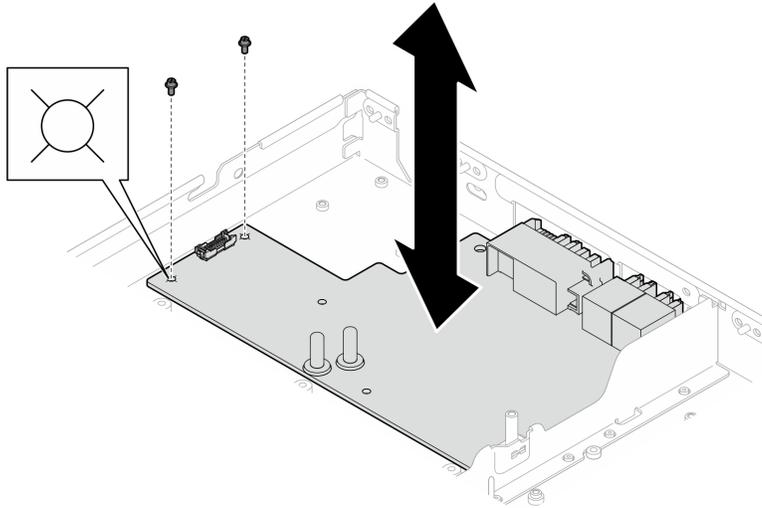
図 396. GPU 分電盤のねじの取り外し
