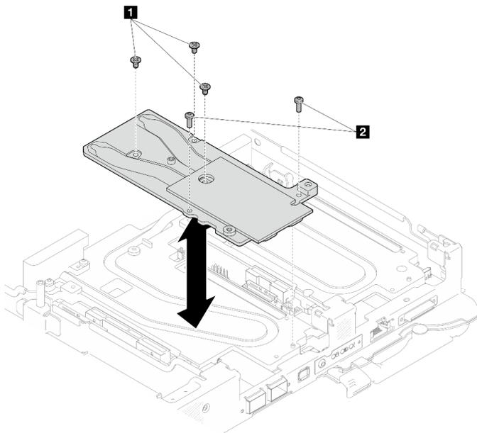
図 239. OSFP モジュール 伝導プレートの取り付け
