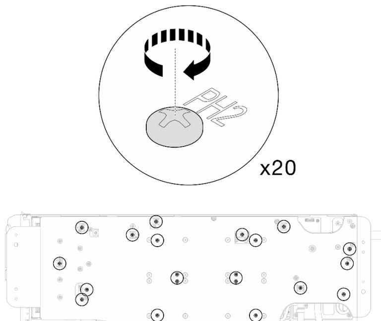
図22. ウォーター・ループねじおよびクイック・コネクットねじの取り外し (GPU ノード)
