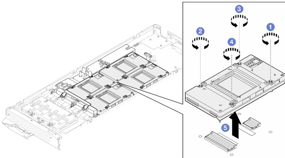
図 336. GPU の取り外し
