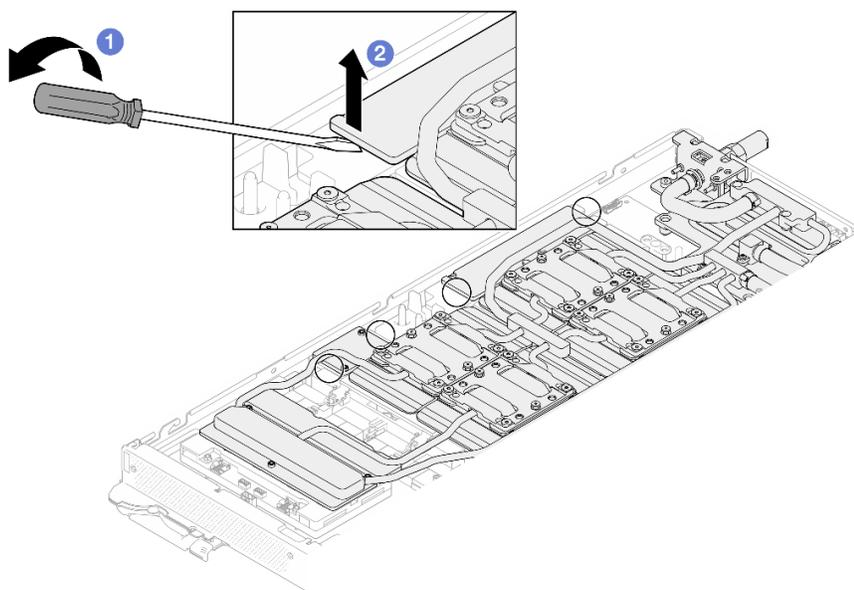
図 328. GPU ボードからの前面と背面の MISC 伝導プレートの取り外し
