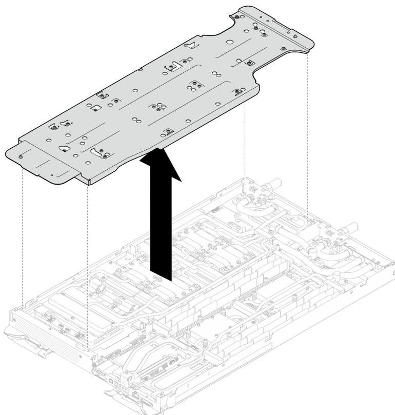
図 345. ウォーター・ループ・キャリアの取り外し (GPU ノード)
