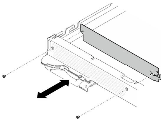
図 449. 通風口ブロックの取り付け
