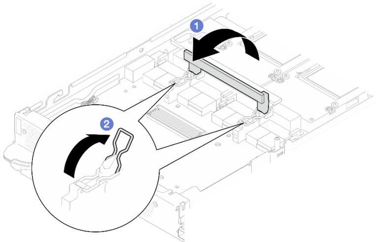
図 354. キャリア・ボードの取り外し
