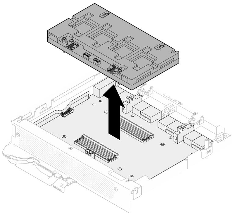
図431. ネットワーク・ボードの取り外し
