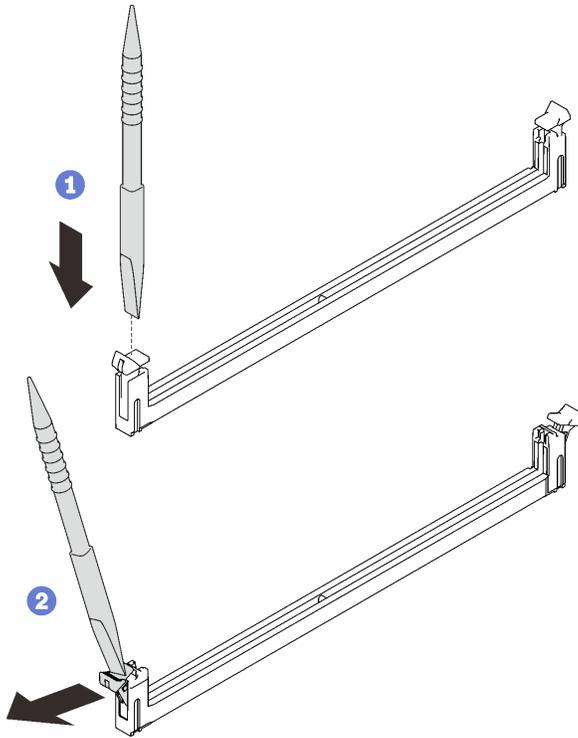
図 162. メモリー・モジュール・コネクタの保持クリップを押す
