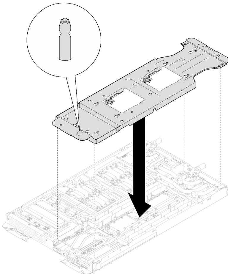
図218. ウォーター・ループ・キャリアの取り付け (計算ノード)
