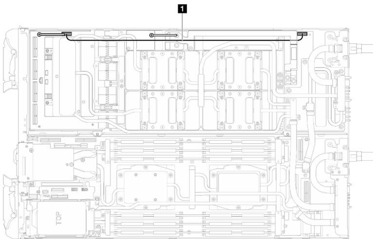
図 415. キャリア・ボードの電源ケーブルの取り外し
