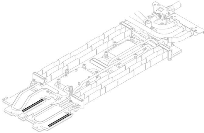
図197. ウォーター・ループ・ギャップ・パッド (上面)
