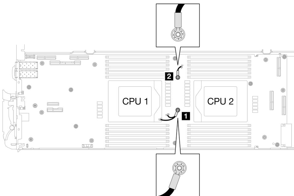
図72. 遮蔽ケーブル 1/2 および遮蔽ケーブル 3 とねじ穴の位置合わせ
