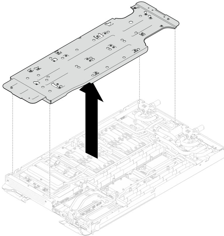
図 406. ウォーター・ループ・キャリアの取り外し (GPU ノード)
