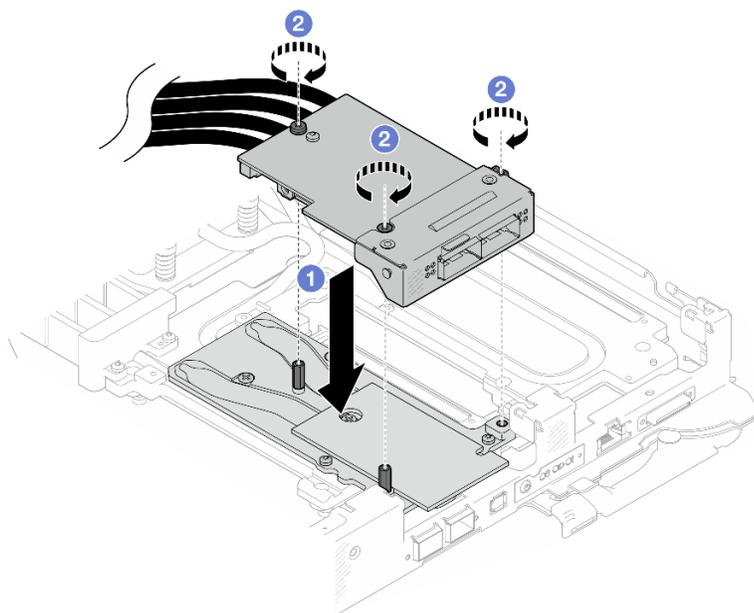
図 176. OSFP モジュールの取り付け
