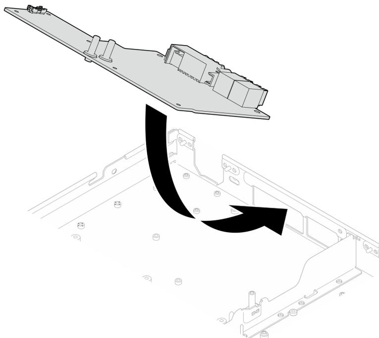
図 399. GPU 分電盤の取り付け
