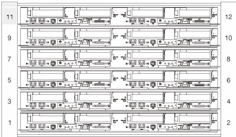
**그림 19. 6개의 SD650 V3 트레이가 설치된 DW612S 엔클로저의 앞면 보기**
