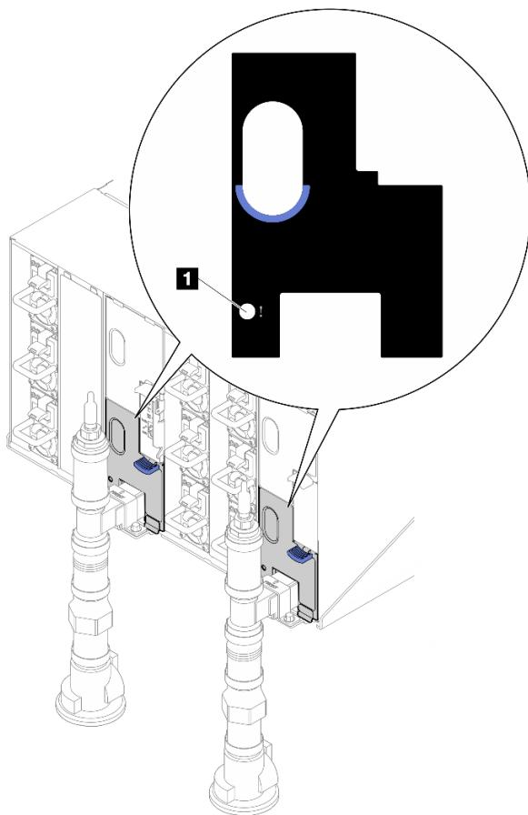
그림 14. 드립 센서 LED
