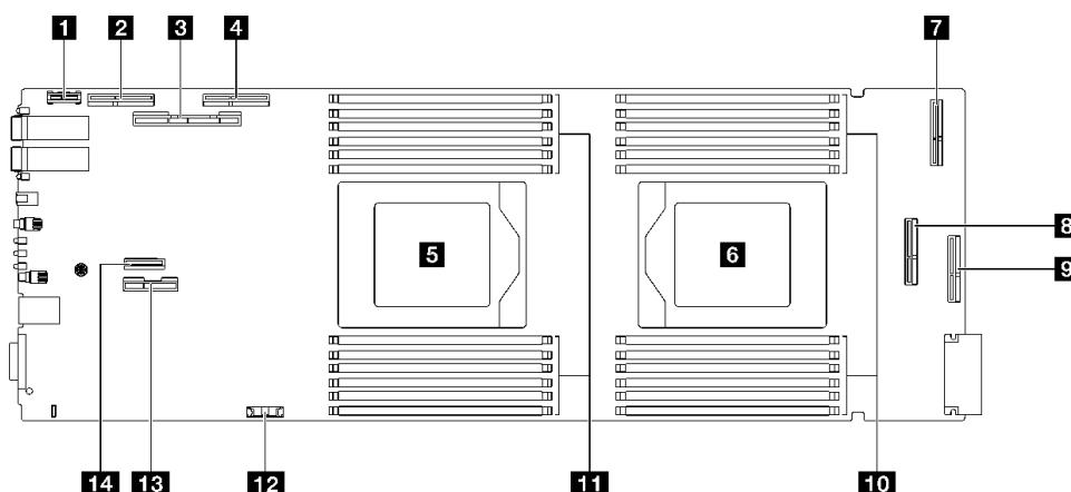
**그림 7. 컴퓨팅 노드의 컴퓨팅 노드 시스템 보드에 있는 내부 커넥터**
