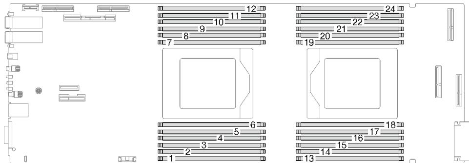
**그림 6. 컴퓨팅 노드 시스템 보드의 DIMM 슬롯 번호**
