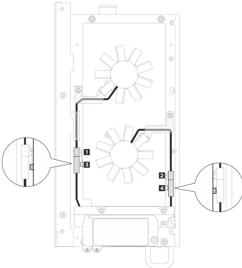
Figura 2. Disposición de los cables del módulo de ventilador y el cable del puente del ventilador
