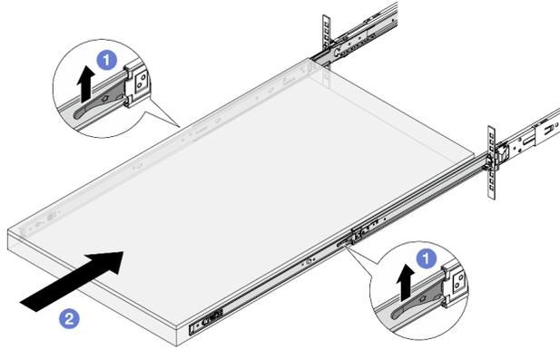
Figure 13. Verrouillage des loquets
