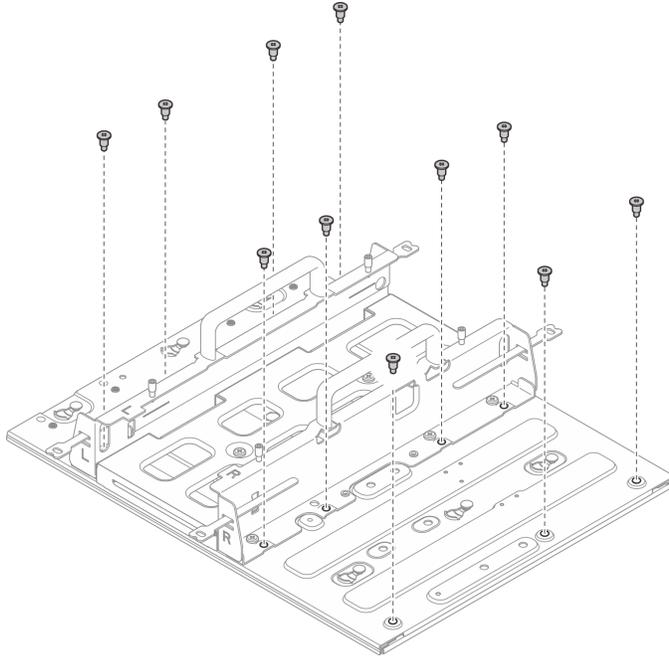
Figure 52. Installation du manchon de nœud sans kit d'extension
