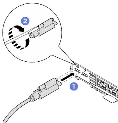
Figure 59. Installation du cordon d'alimentation
