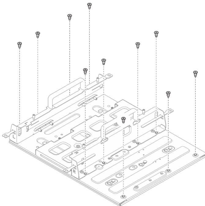
Figure 51. Installation du manchon de nœud avec le kit d'extension
