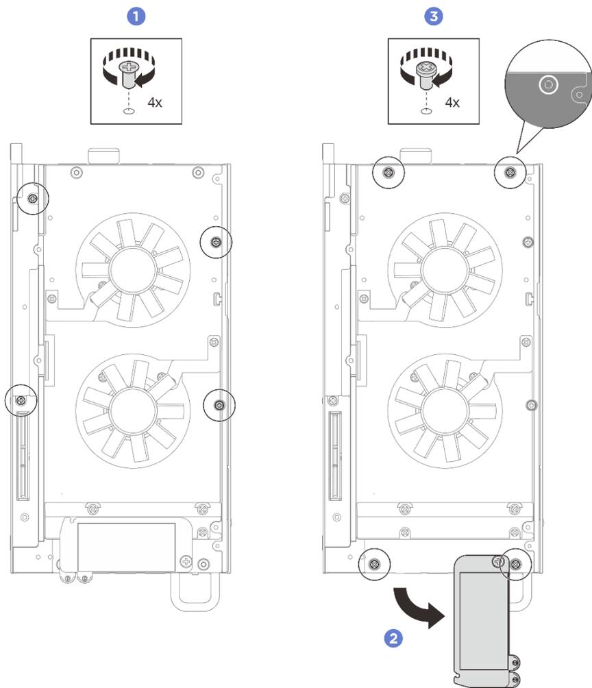
Figure 129. Installation des vis
