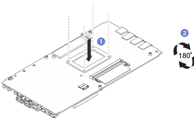
Figure 142. Installation de la plaque arrière du processeur
