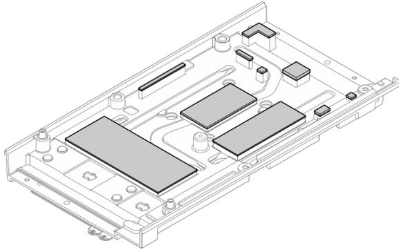
Figure 140. Tampons thermiques du capot supérieur
