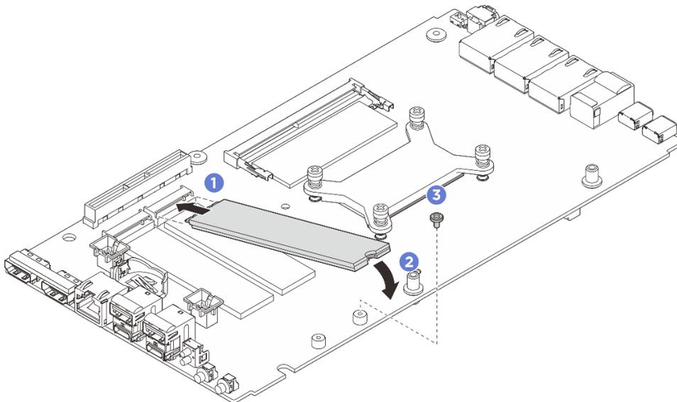
Figure 113. Installation d'unité M.2 de type 22110
