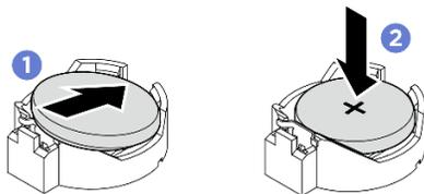
Figure 77. Installation de la pile CMOS
