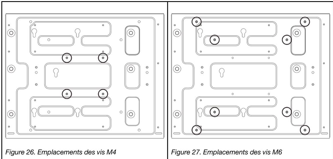
Figure 26. Emplacements des vis M4
