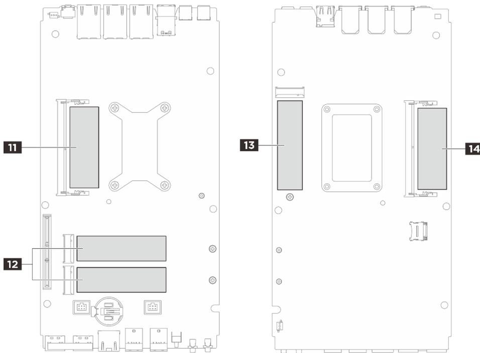
Figure 4. Carte mère – Identification et emplacement des kits de tampons thermiques
