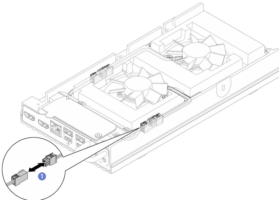
Figure 96. Déconnexion du câble de la passerelle du ventilateur
