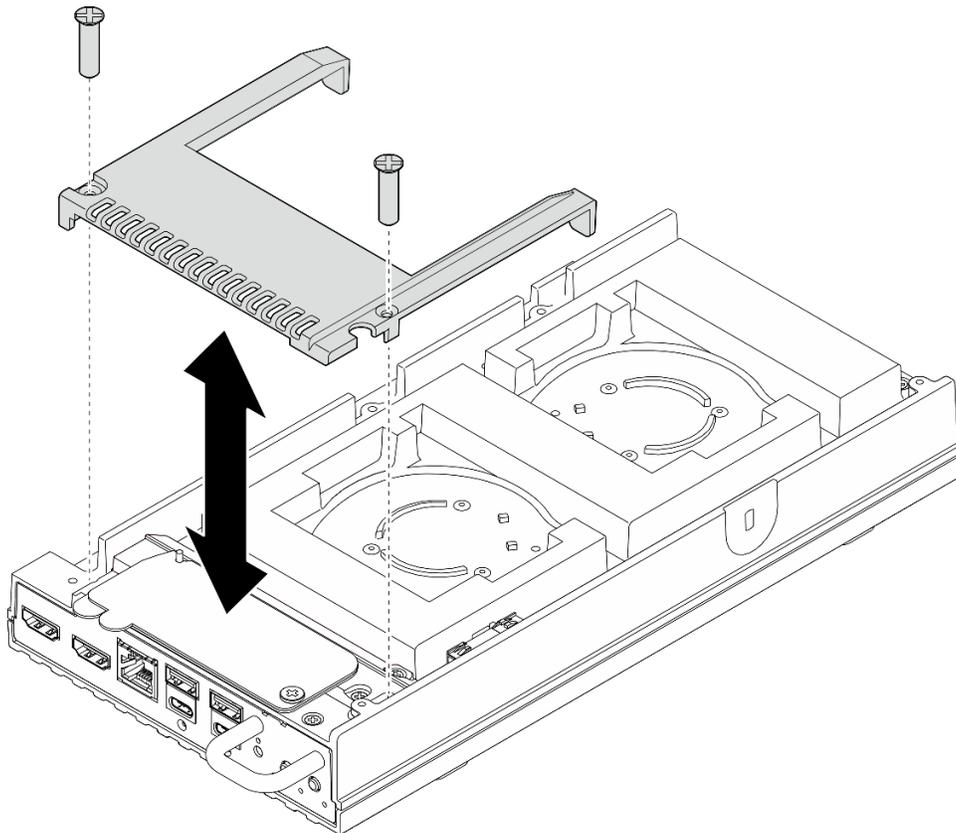
Figure 90. Retrait du capotage de ventilateur
