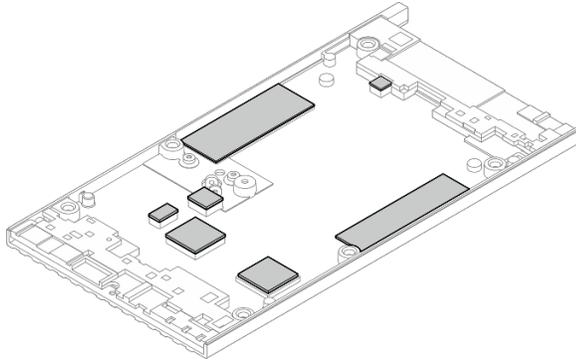
Figure 152. Tampons thermiques du carter inférieur
