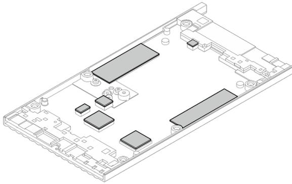
Figure 141. Tampons thermiques du carter inférieur
