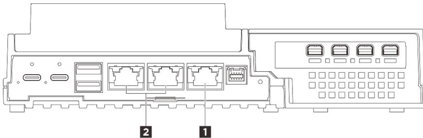
Figure 188. Voyant Port de gestion du système XCC (10/100/1000 Mbit/s RJ-45) et voyants du port LAN
