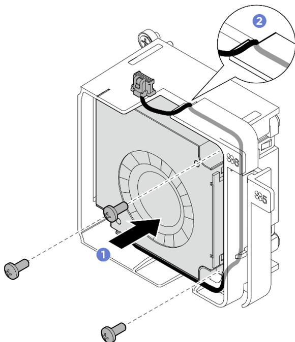
Figure 171. Installation du ventilateur 6
