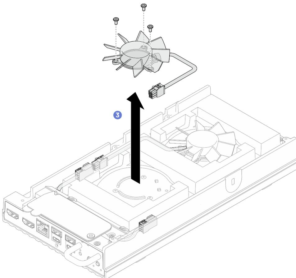
Figure 99. Retrait du module de ventilation
