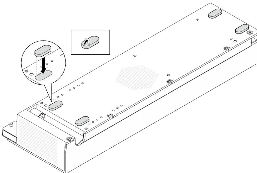
Figure 57. Installation des pieds en caoutchouc sur le kit d'extension PCIe
