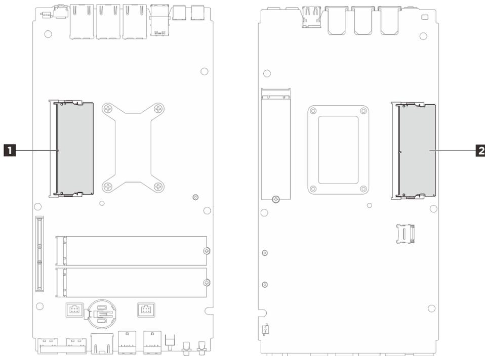
Figure 116. Disposition des modules de mémoire et des processeurs
