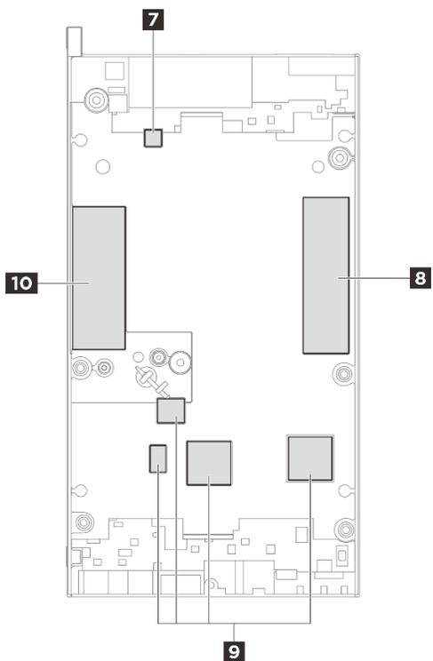
Figure 3. Carter inférieur – Identification et emplacement des kits de tampons thermiques
