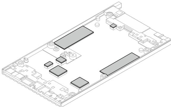
Figure 133. Tampons thermiques du carter inférieur
