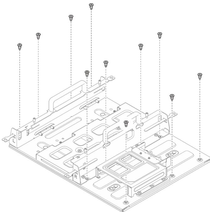
Figure 40. Retrait du manchon de nœud avec le kit d'extension
