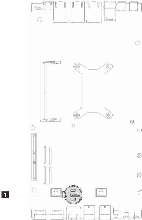
Figure 74. Emplacement de la pile CMOS
