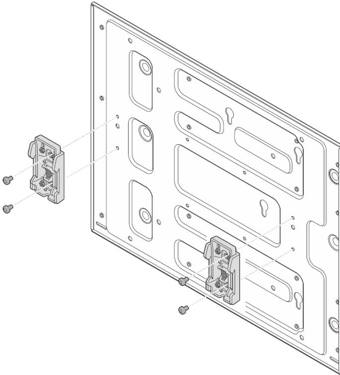
Figure 44. Retrait des clips de la glissière DIN
