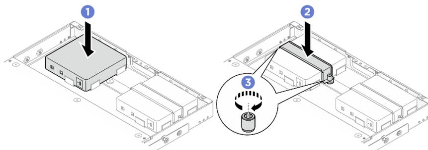
Figure 71. Installation du boîtier d'alimentation
