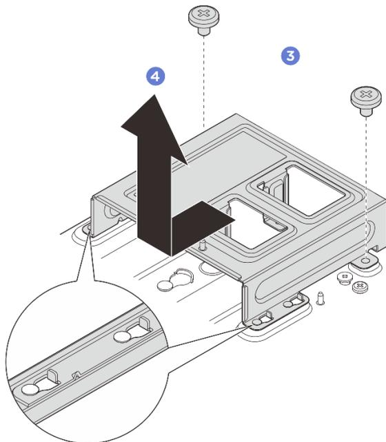
Figure 63. Retrait du le boîtier d'adaptateur d'alimentation
