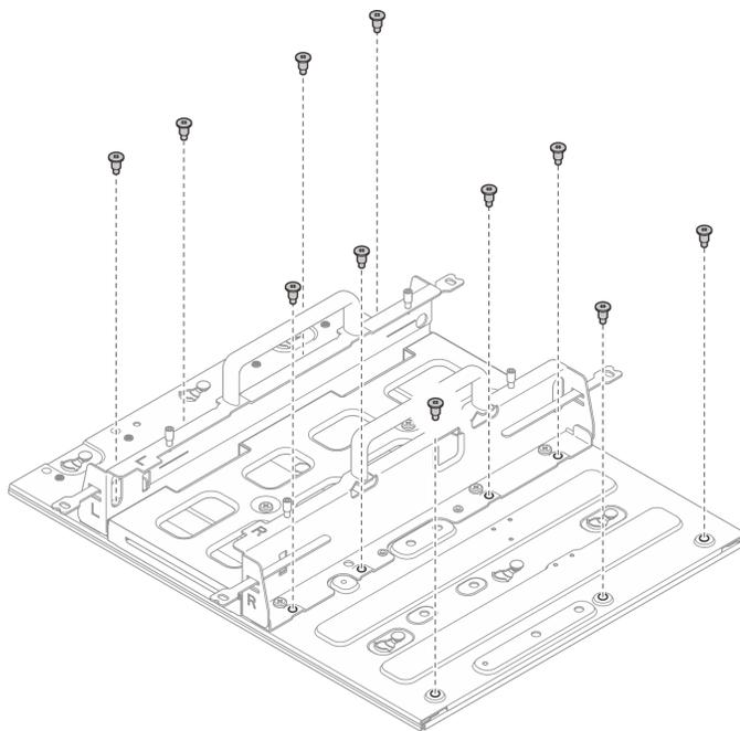
Figure 37. Installation du manchon de nœud sans kit d'extension
