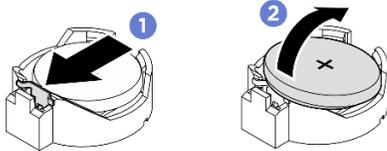
Figure 75. Retrait de la pile CMOS
