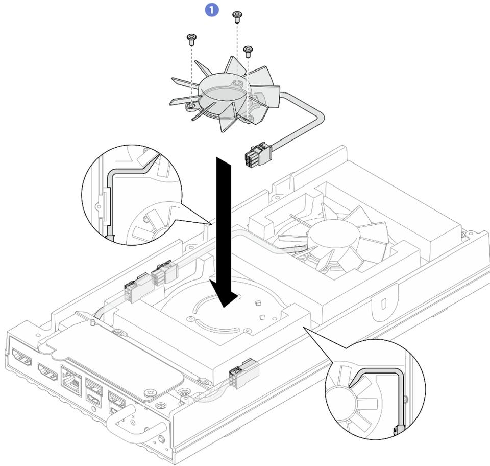
Figure 100. Installation du module de ventilation
