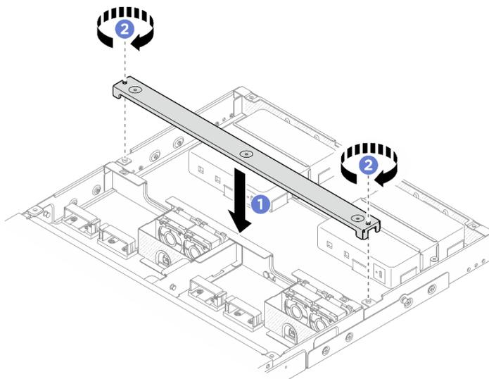
Figure 73. Installation de la traverse
