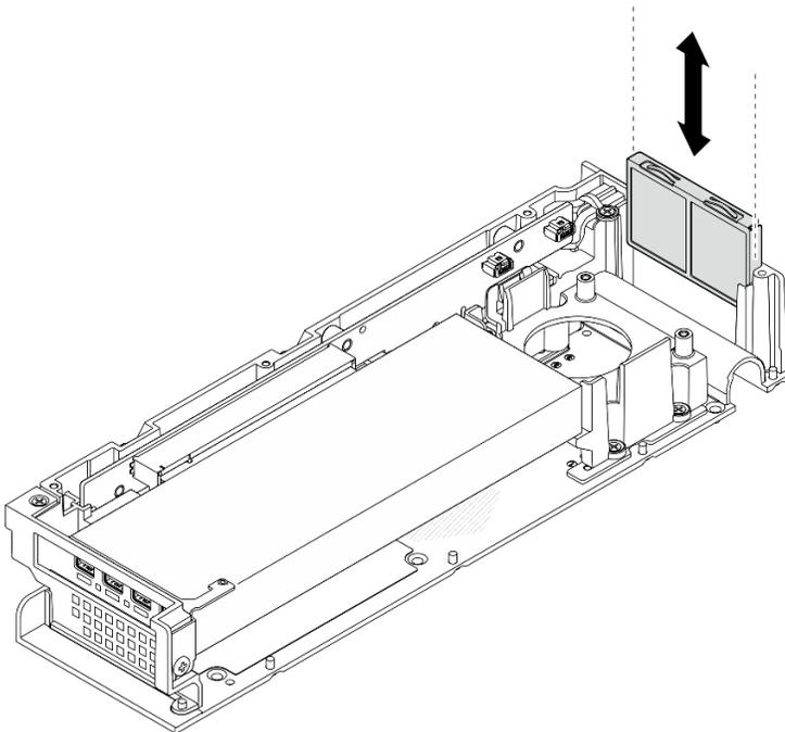
Figure 161. Installation du support de filtre antipoussière
