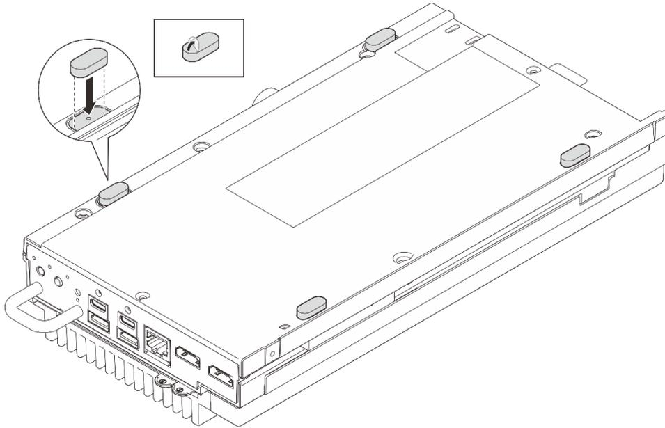
Figure 56. Installation des pieds en caoutchouc sur le nœud
