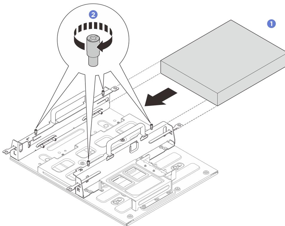
Figure 53. Installation d'un nœud dans un manchon de nœud
