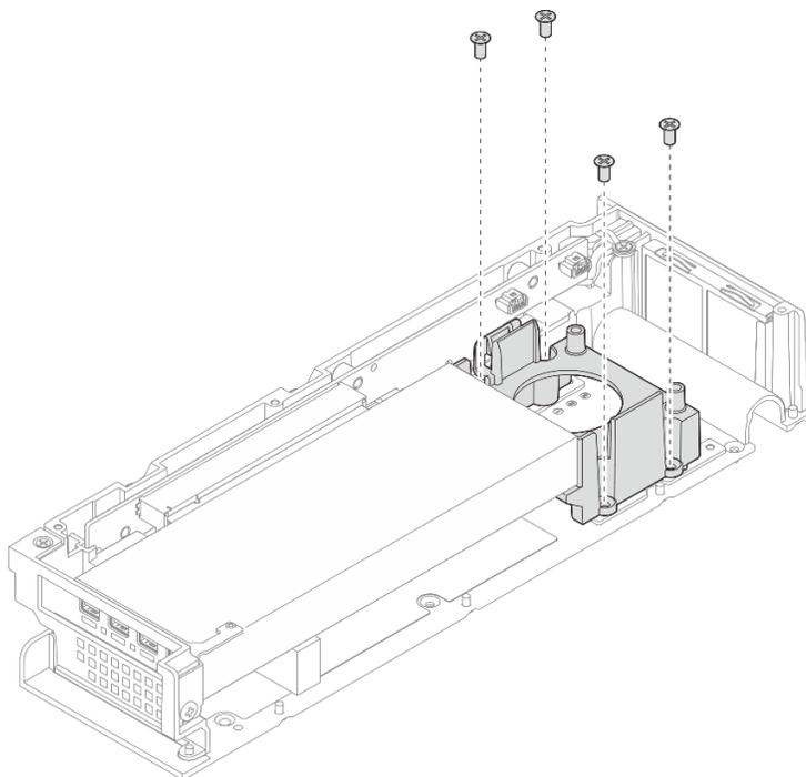
Figure 174. Installation de la grille de support
