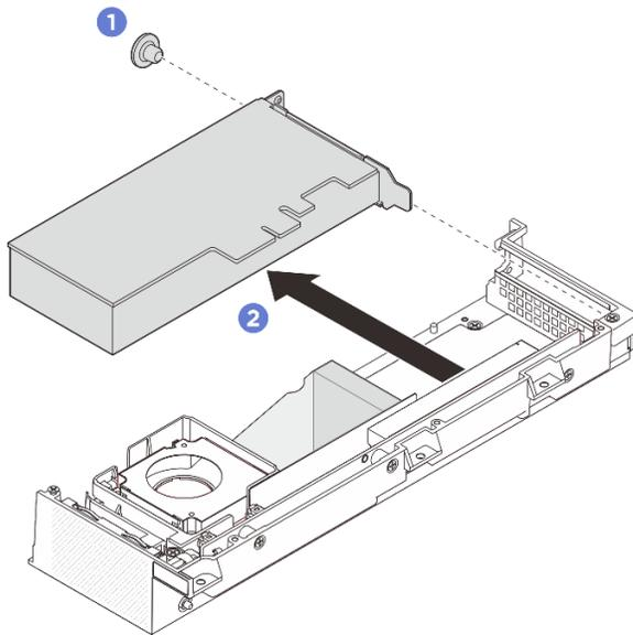
Figure 177. Retirer un adaptateur PCIe
