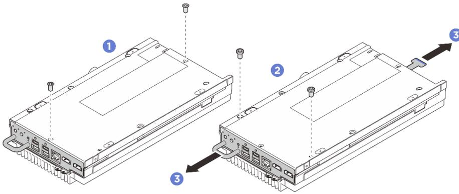
Figure 125. Retrait des supports d'E-S avant et arrière
