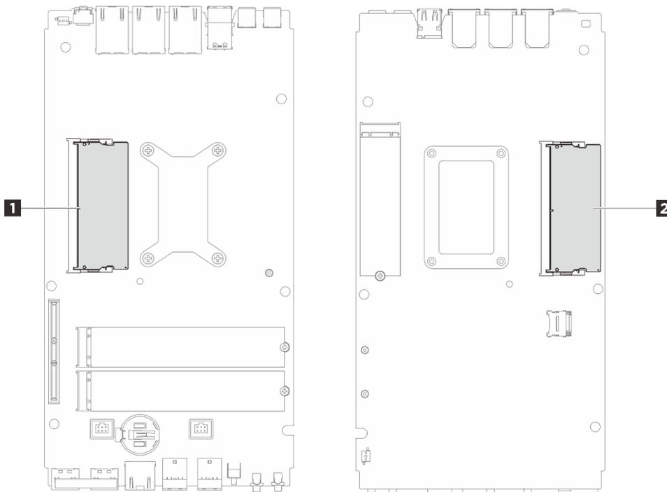
Figure 118. Disposition des modules de mémoire et des processeurs
