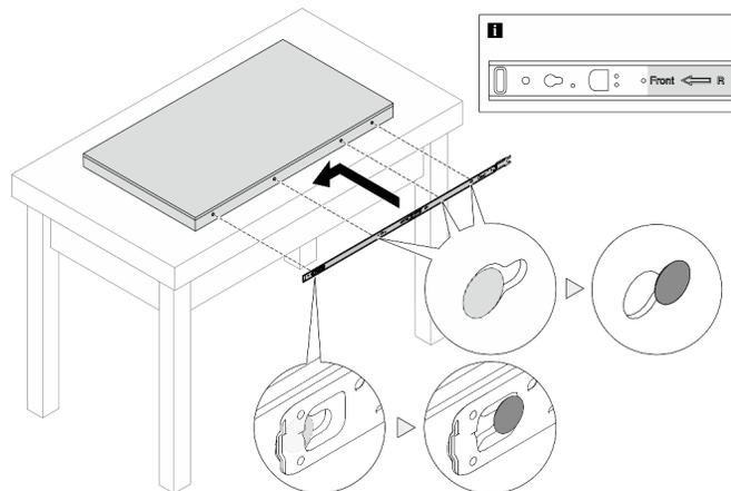
Figure 10. Installation d'une glissière interne dans le serveur
