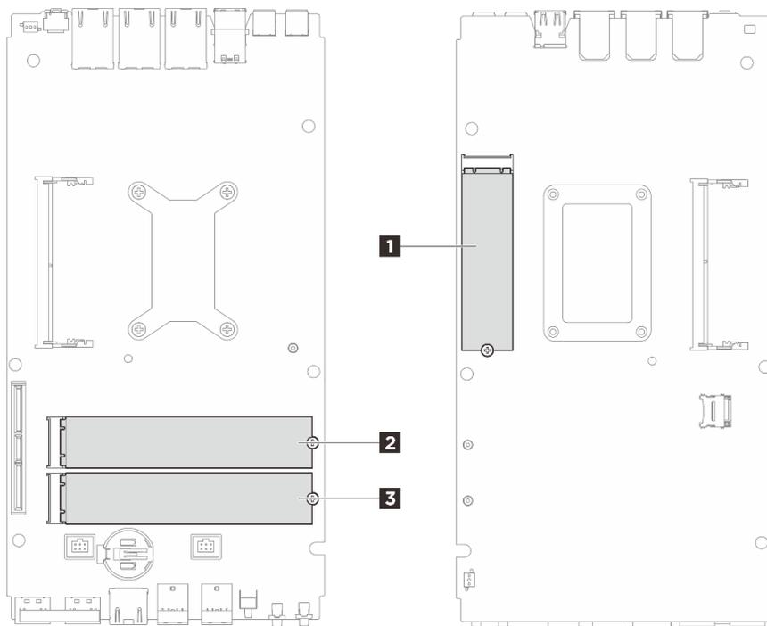
Figure 104. Numérotation des emplacements d'unités M.2
