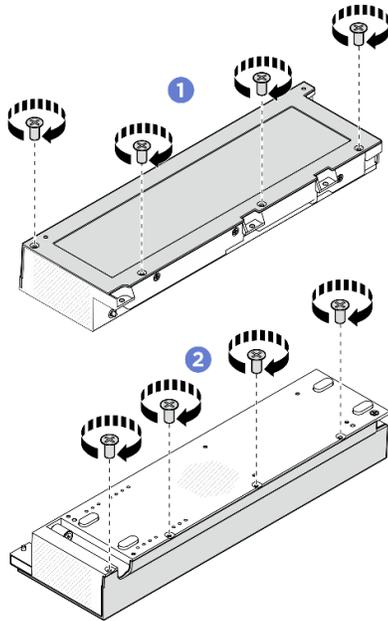
Figure 165. Installation du carter supérieur d'extension
