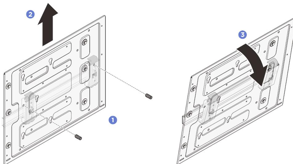
Figure 43. Retrait de la plaque de montage sur rail DIN
