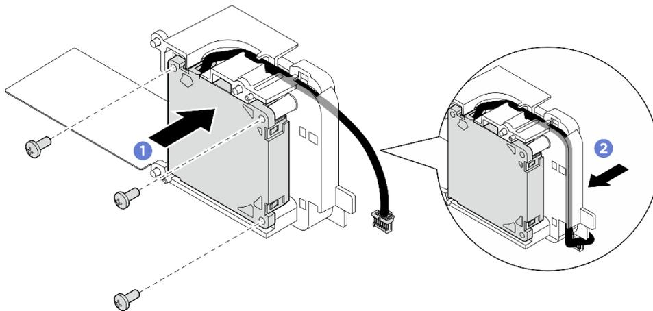
Figure 170. Installation du ventilateur 5
