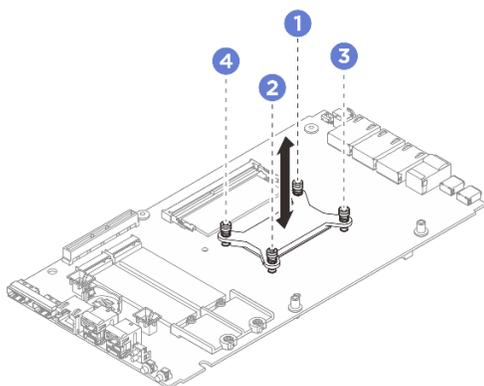
Figure 139. Retrait du dissipateur thermique de processeur
