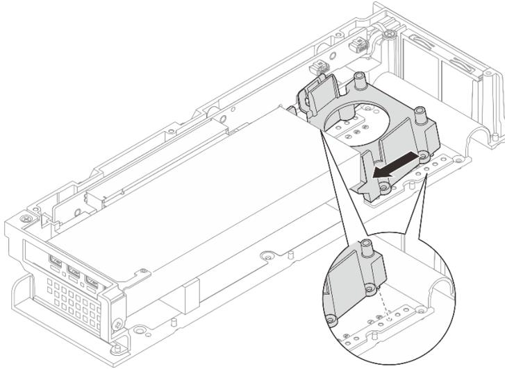
Figure 173. Installation de la grille de support
