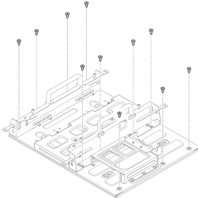
Figure 45. Retrait du manchon de nœud avec le kit d'extension
