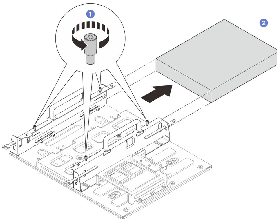
Figure 21. Retrait d'un nœud d'un manchon de nœud
