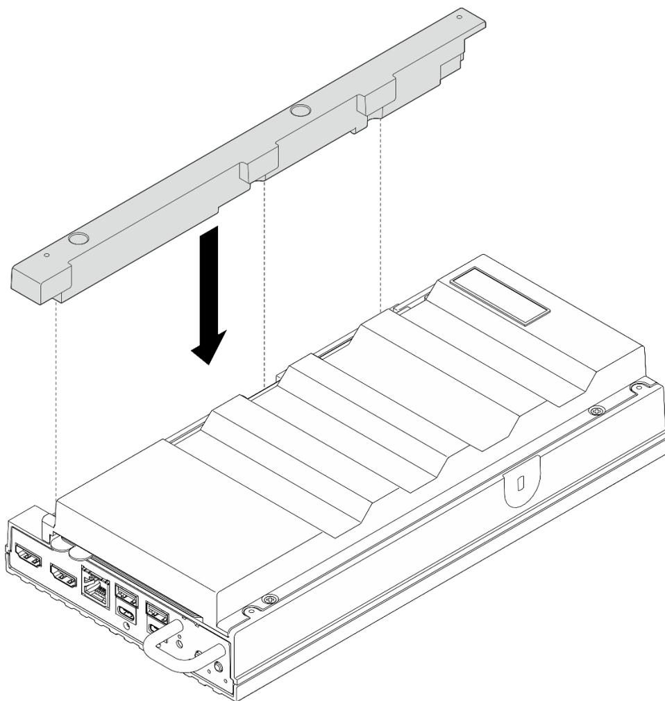
Figure 79. Installation de l'obturateur d'extension
