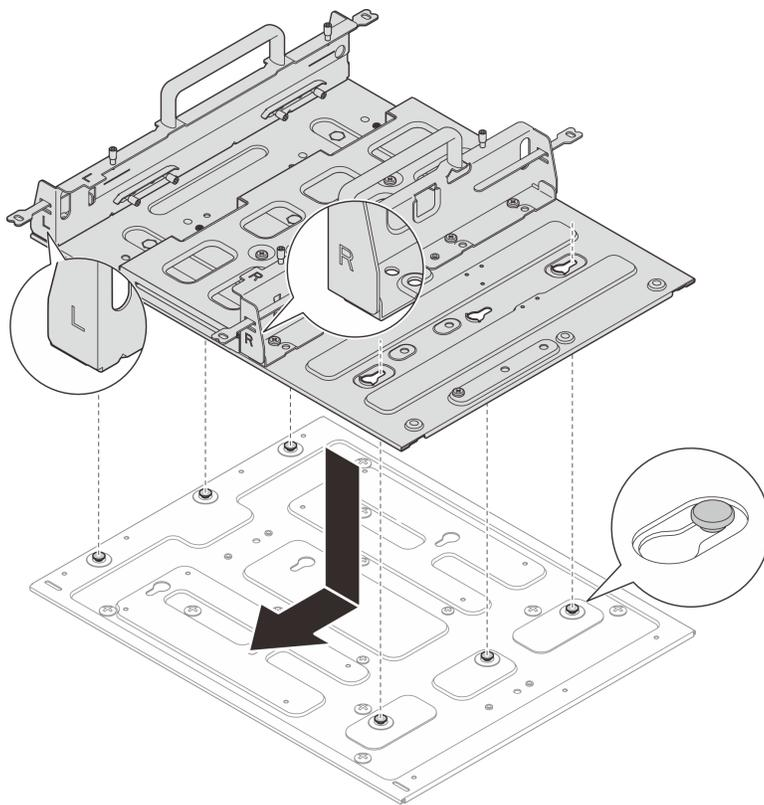
Figure 50. Installation d'un manchon de nœud
