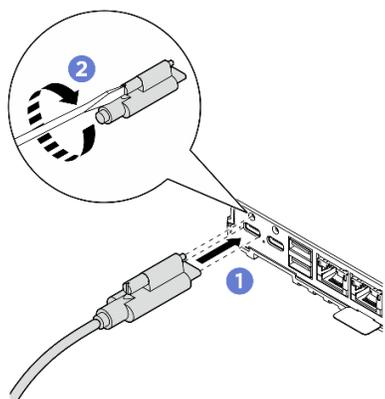
Figure 72. Installation du cordon d'alimentation
