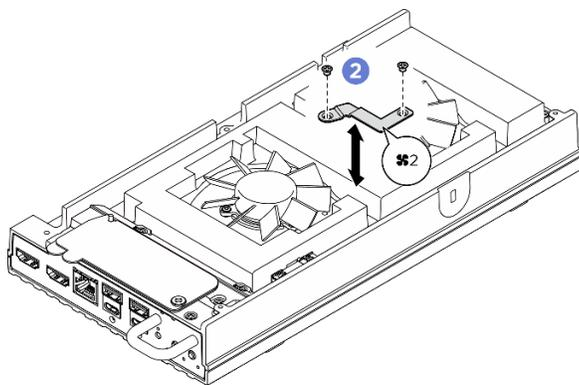
Figure 98. Emplacement des vis du support du ventilateur 2
