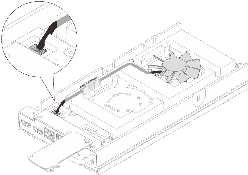
Figure 85. Cheminement des câbles pour le connecteur de ventilateur 1
