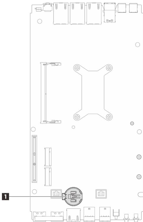
Figure 76. Emplacement de la pile CMOS
