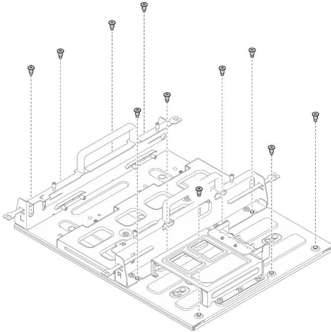
Figure 28. Retrait du manchon de nœud avec le kit d'extension
