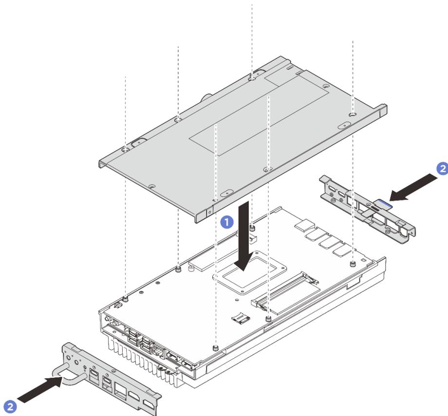
Figure 155. Installation du carter inférieur
