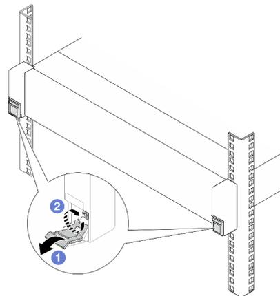
Figure 14. Fixation du serveur à l'avant de l'armoire
