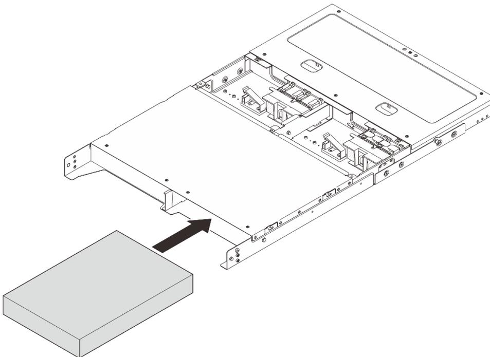
Figure 17. Installation du nœud
