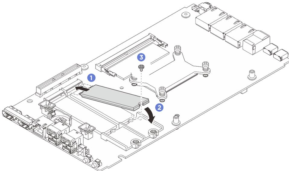
Figure 115. Installation de l'unité M.2 de type 2280
