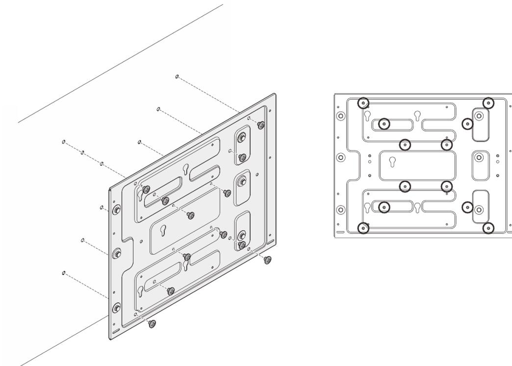
Figure 32. Installation de la plaque de montage mural
