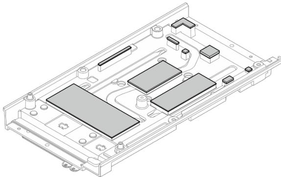
Figure 127. Tampons thermiques du capot supérieur
