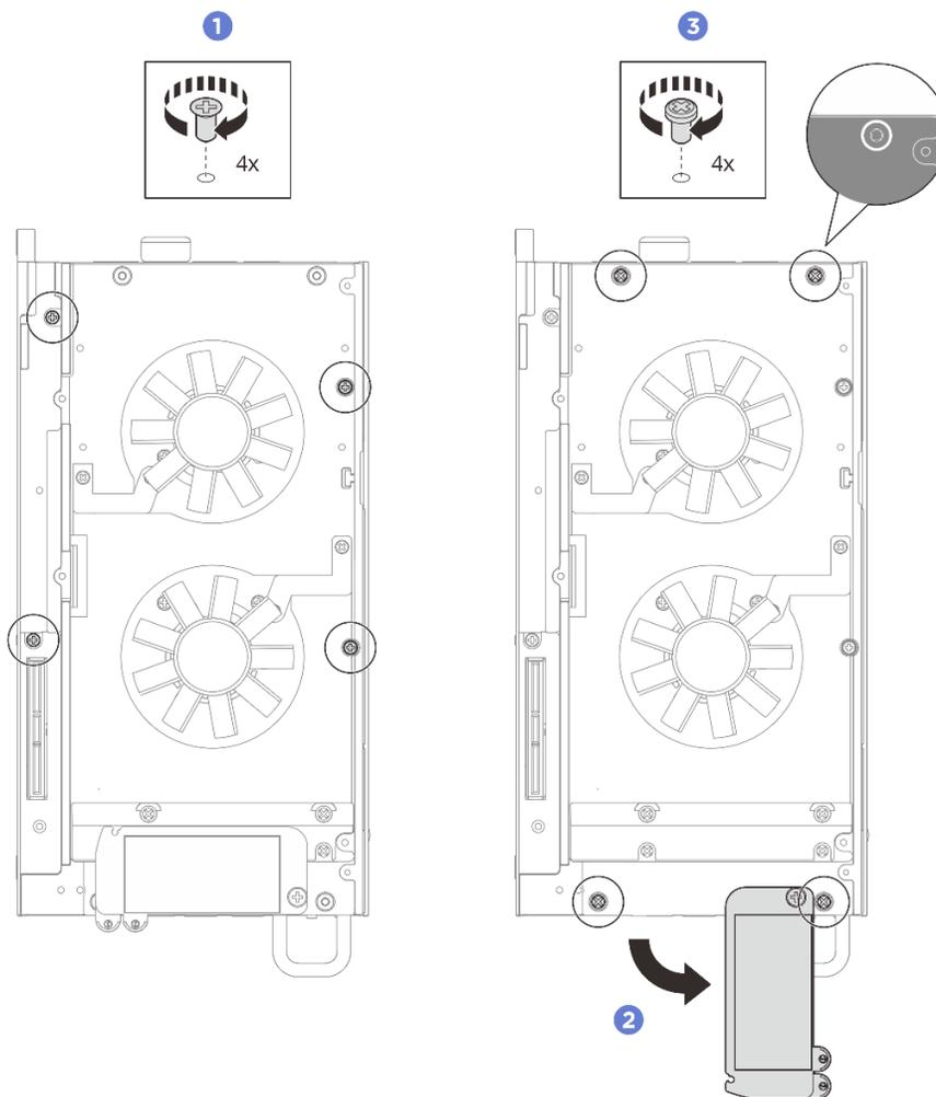
Figure 157. Installation des vis
