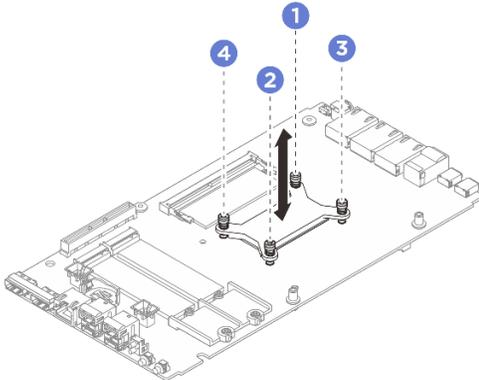
Figure 143. Installation du dissipateur thermique de processeur
