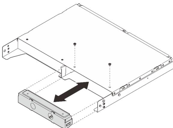
Figure 8. Installation de l'obturateur de nœud
