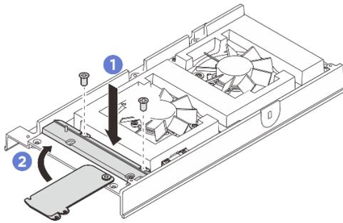
Figure 87. Installation du couvre-câble de passerelle du ventilateur
