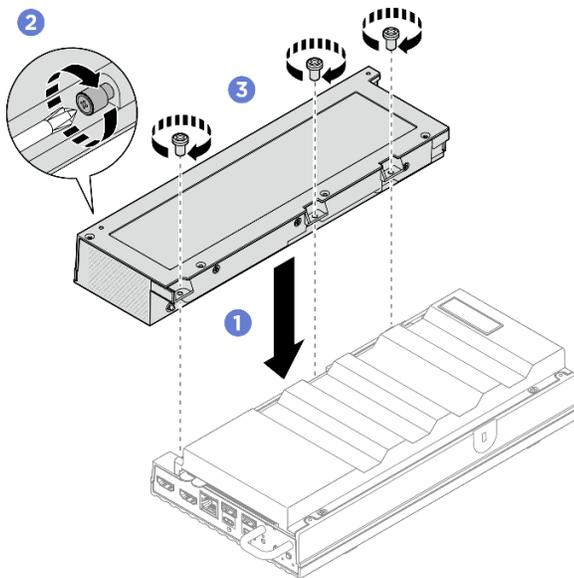
Figure 163. Installation du kit d'extension
