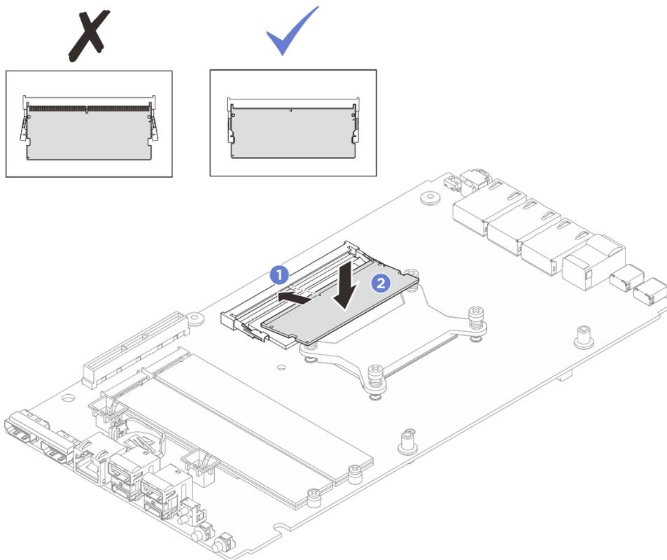
Figure 121. Installation du module de mémoire
