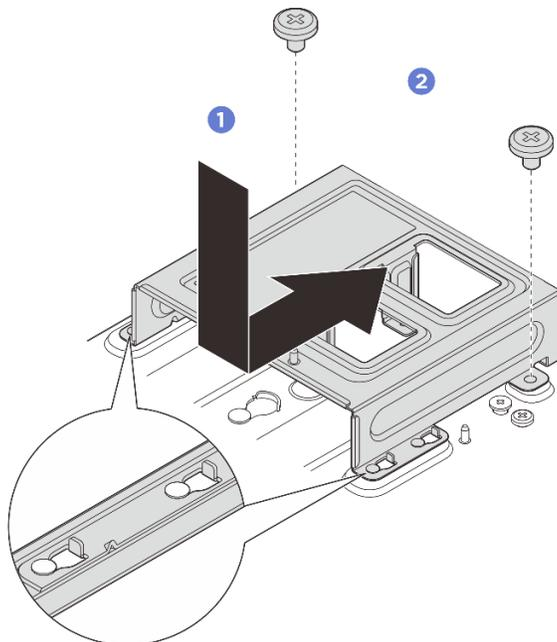
Figure 64. Installation du support d'adaptateur d'alimentation
