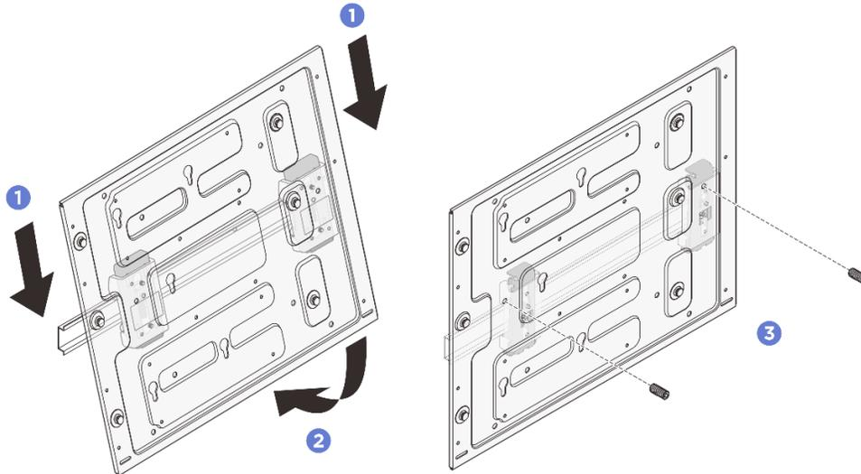
Figure 49. Installation de la plaque de montage sur rail DIN
