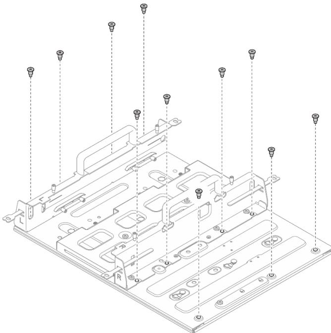
Figure 36. Installation du manchon de nœud avec le kit d'extension
