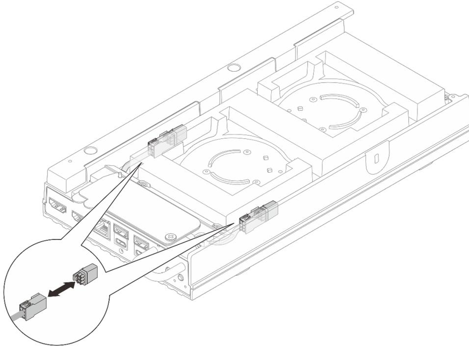
Figure 94. Installation d'un obturateur antipoussière pour câble de passerelle de ventilateur
