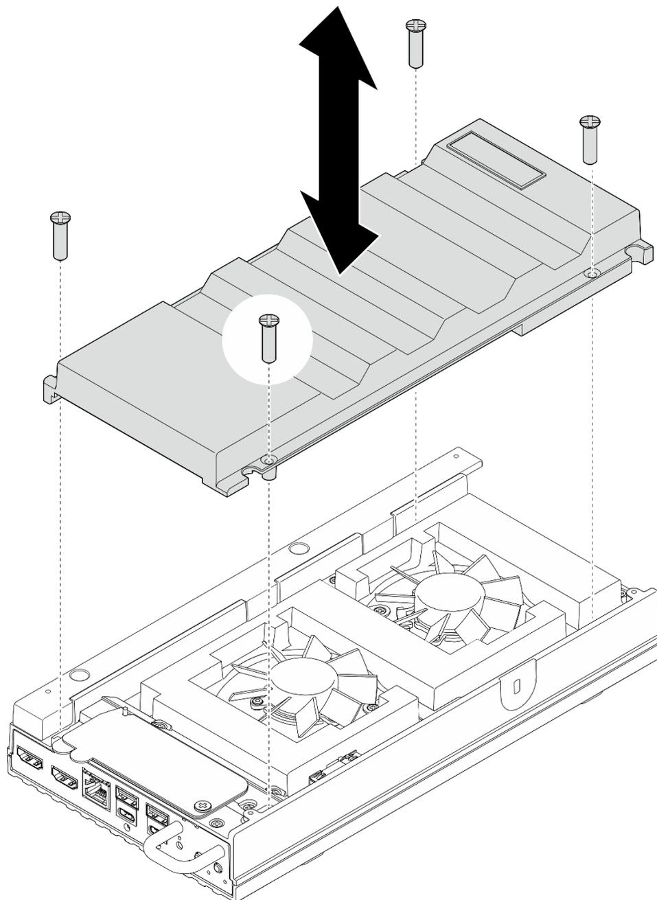
Figure 93. Installation d'un capotage de ventilateur
