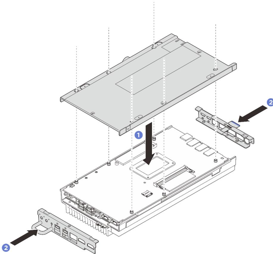
Figure 134. Installation du carter inférieur
