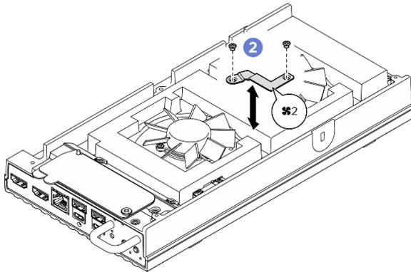
Figure 102. Emplacement des vis du support du ventilateur 2
