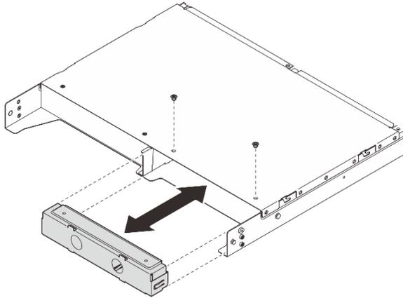
Figure 18. Installation de l'obturateur de nœud
