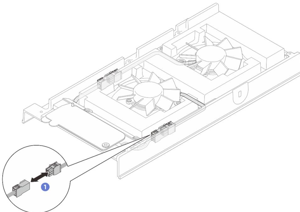
Figure 82. Déconnexion du câble de la passerelle du ventilateur
