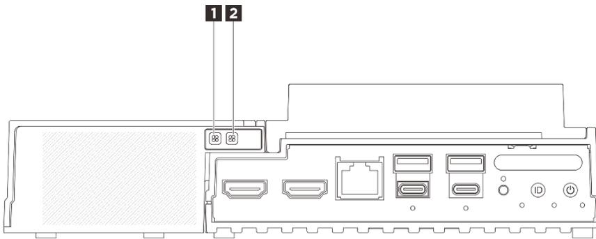
Figure 182. Voyants du kit d'extension de l'adaptateur Ethernet
