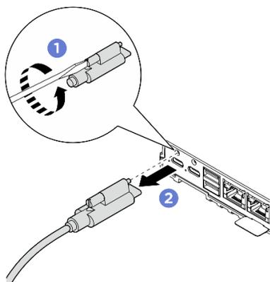
Figure 58. Déconnexion du boîtier d'alimentation
