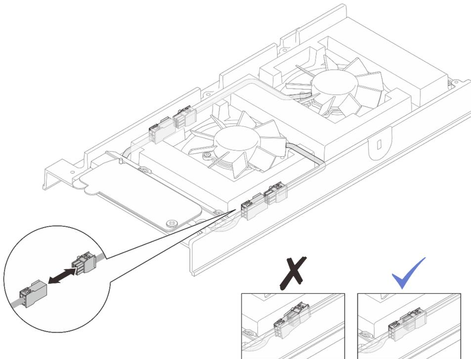
Figure 88. Reconnexion du câble de passerelle du ventilateur
