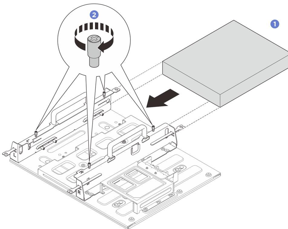
Figure 38. Installation d'un nœud dans un manchon de nœud
