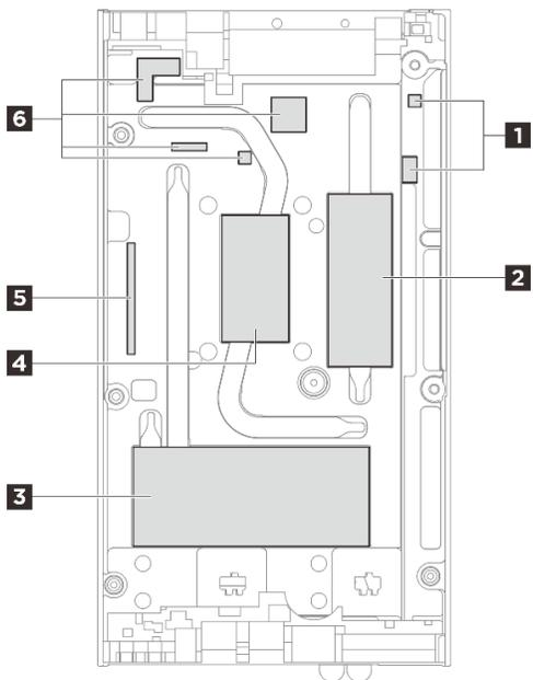
Figure 2. Carter supérieur – Identification et emplacement des kits de tampons thermiques
