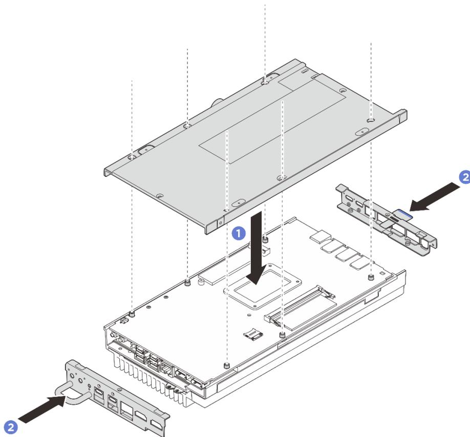
Figure 145. Installation du carter inférieur
