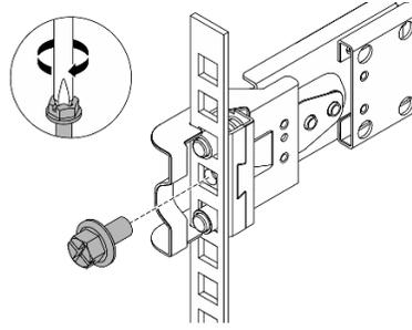
Figure 15. Fixation du serveur à l'arrière de l'armoire
