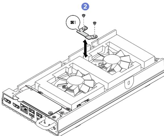
Figure 97. Emplacement des vis du support du ventilateur 1
