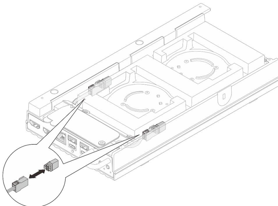
Figure 91. Retrait du filtre antipoussière du câble de passerelle du ventilateur
