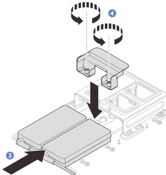
Figure 66. Installation du boîtier d'alimentation
