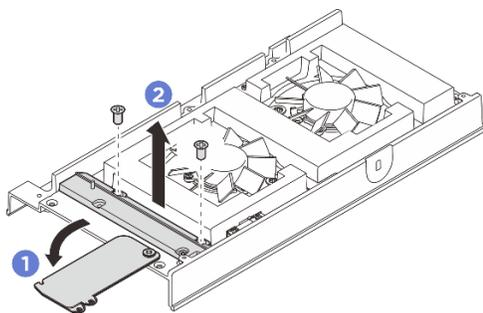
Figure 81. Retrait du couvre-câble de la passerelle du ventilateur
