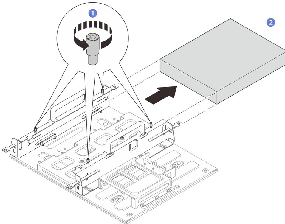
Figure 39. Retrait d'un nœud d'un manchon de nœud
