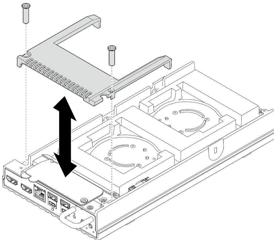
Figure 95. Installation d'un capotage de ventilateur
