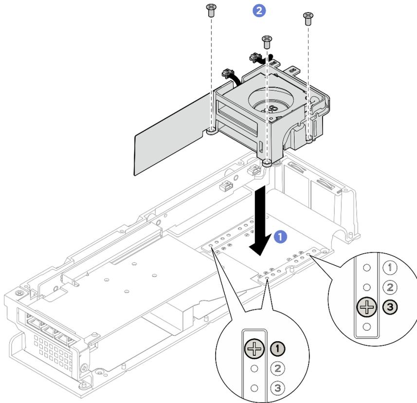
Figure 167. Installation du module de ventilation
