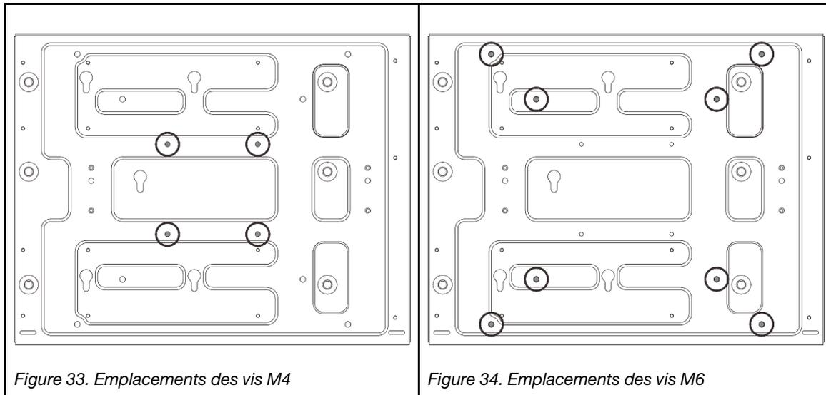
Figure 33. Emplacements des vis M4
