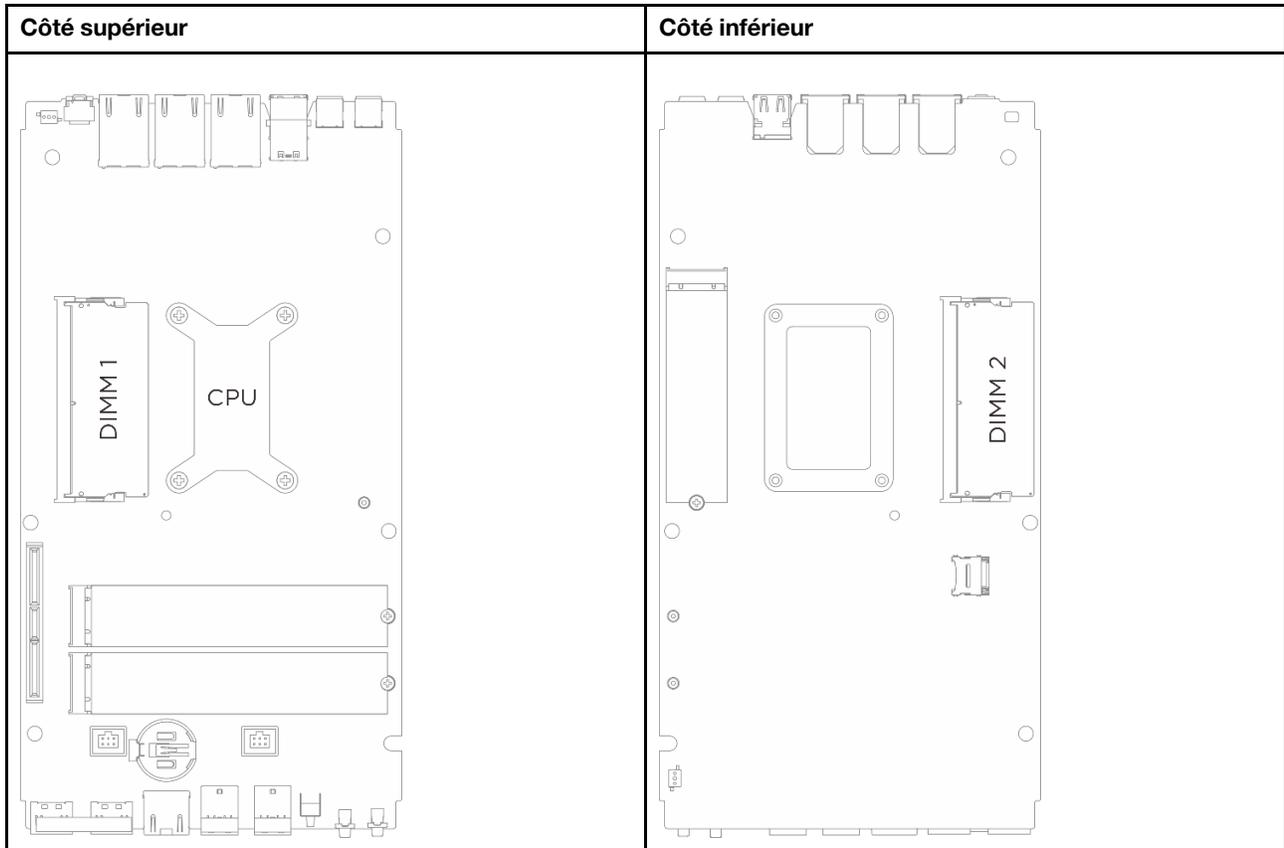
Figure 1. Disposition des modules de mémoire et des processeurs
