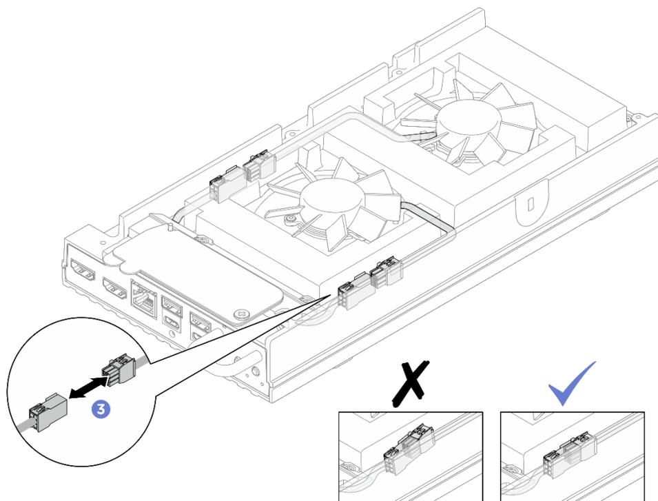
Figure 103. Connexion du câble de la passerelle du ventilateur
