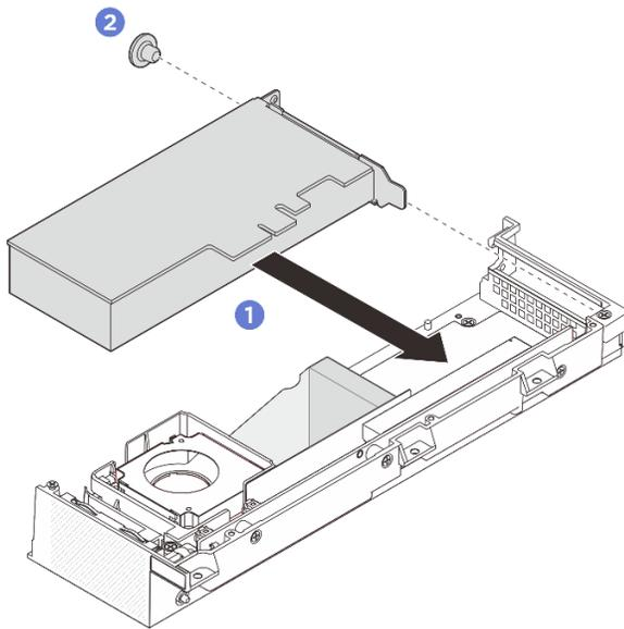
Figure 178. Installation d'un adaptateur PCIe
