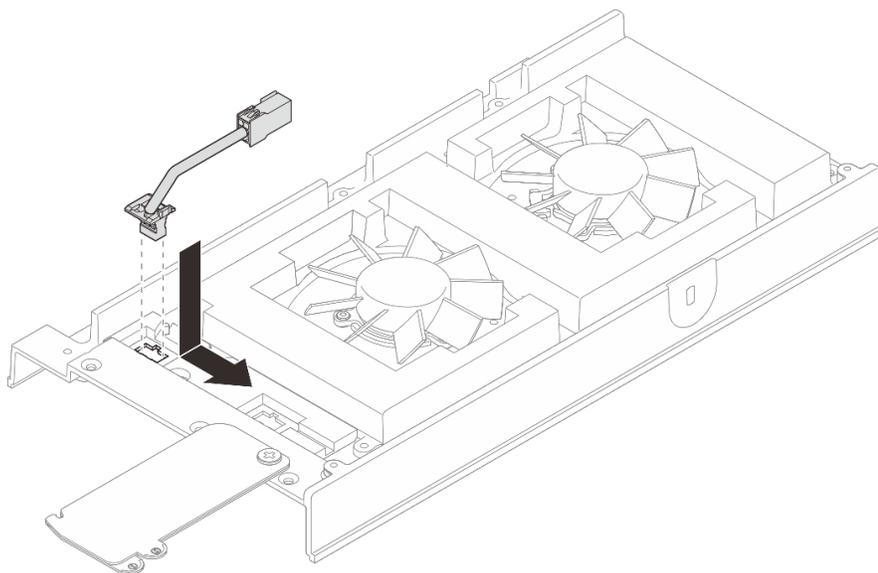
*Figure 84. Installation du câble de passerelle du ventilateur*
