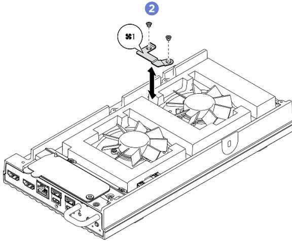
Figure 101. Emplacement des vis du support du ventilateur 1
