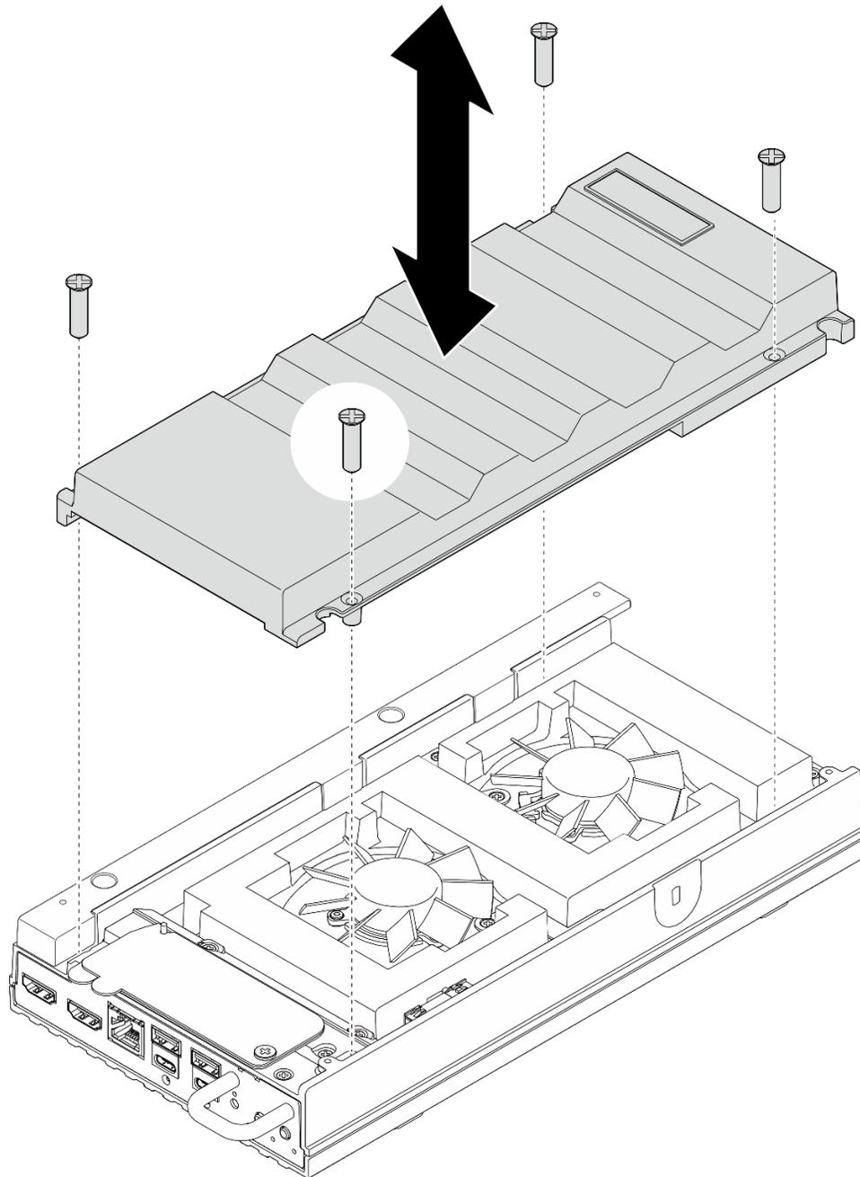
Figure 89. Retrait du capotage de ventilateur
