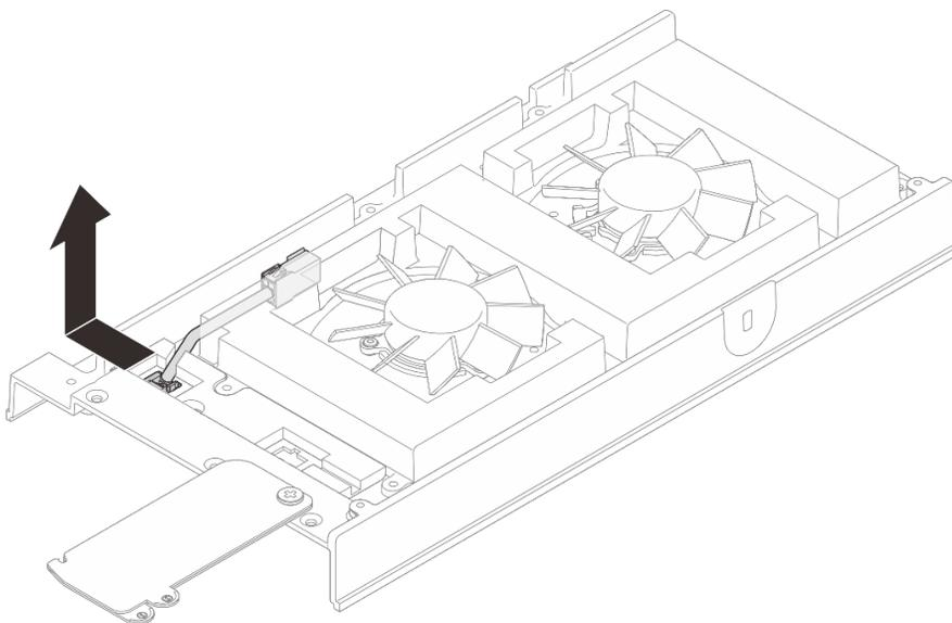
Figure 83. Retrait du câble de passerelle du ventilateur
