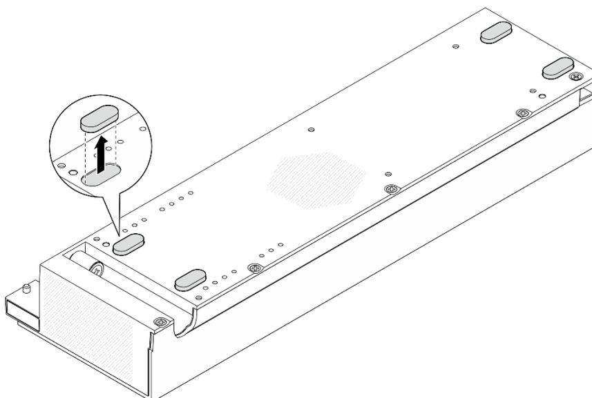
Figure 55. Retrait des pieds en caoutchouc du kit d'extension PCIe
