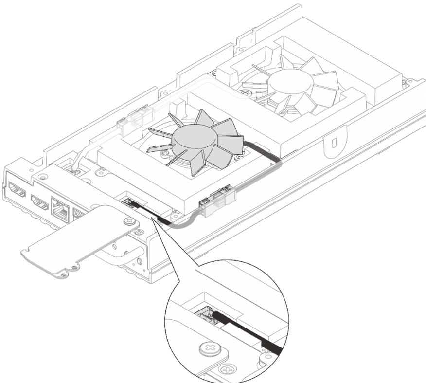
Figure 86. Cheminement des câbles pour le connecteur de ventilateur 2
