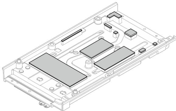
Figure 151. Tampons thermiques du capot supérieur
