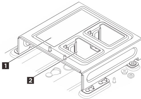
Figure 61. Numérotation des emplacements des adaptateurs d'alimentation
