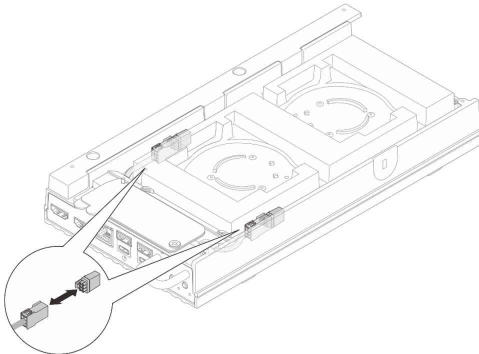
*Figure 92. Retrait du filtre antipoussière du câble de passerelle du ventilateur*
