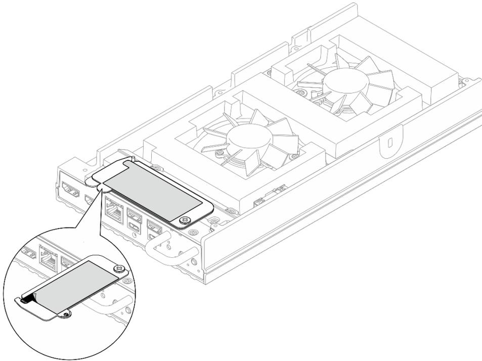
Figure 153. Étiquette d'accès réseau Lenovo XClarity Controller figurant sur l'étiquette amovible
