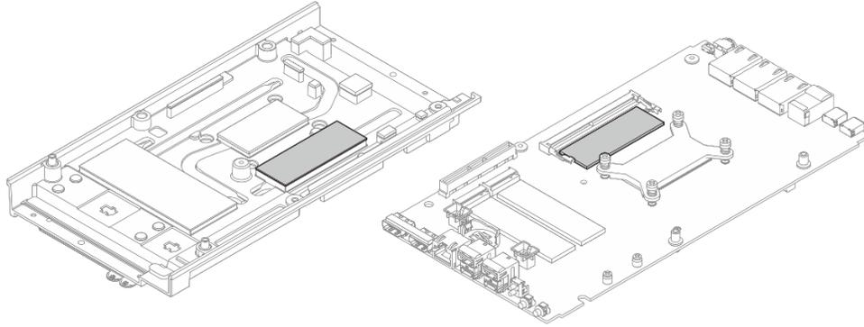
Figure 120. Tampons thermiques de l'emplacement du module de mémoire 2 (côté carter inférieur et carte mère)
