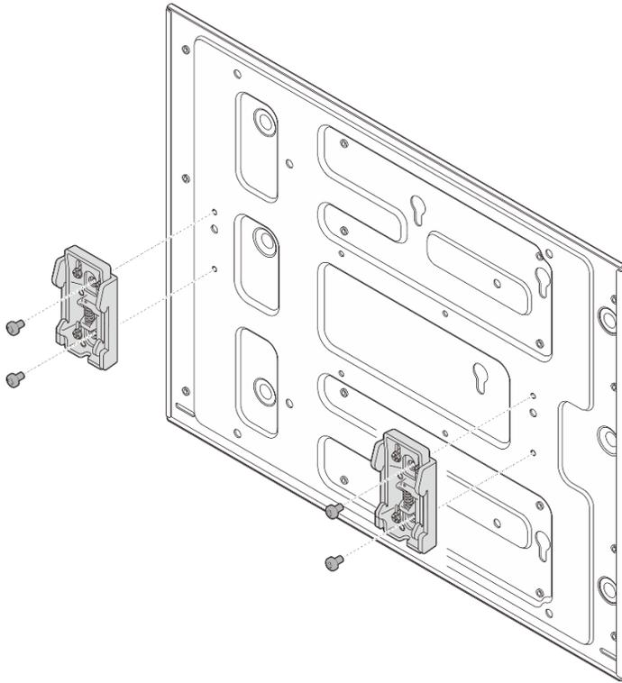
Figure 48. Installation des clips pour la glissière DIN
