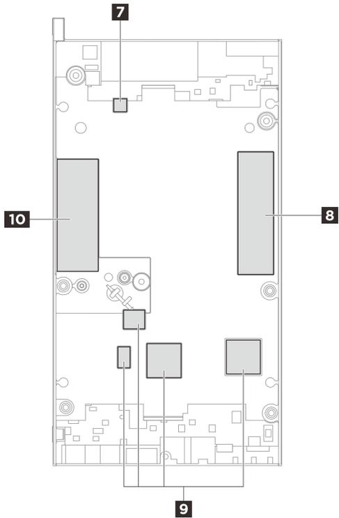
图 3. 底盖 — 导热垫套件的标识和位置
