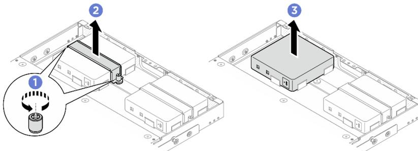
图 70. 卸下电源适配器
