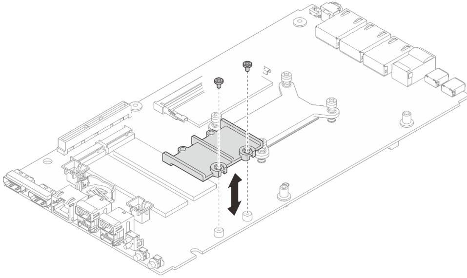
图 114. 安装 M.2 夹持器
