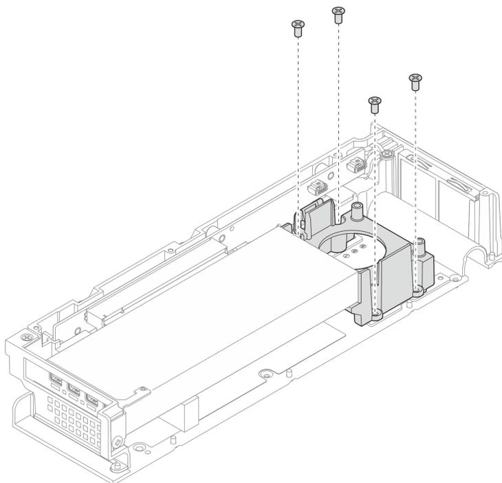
图 174. 安装支撑罩
