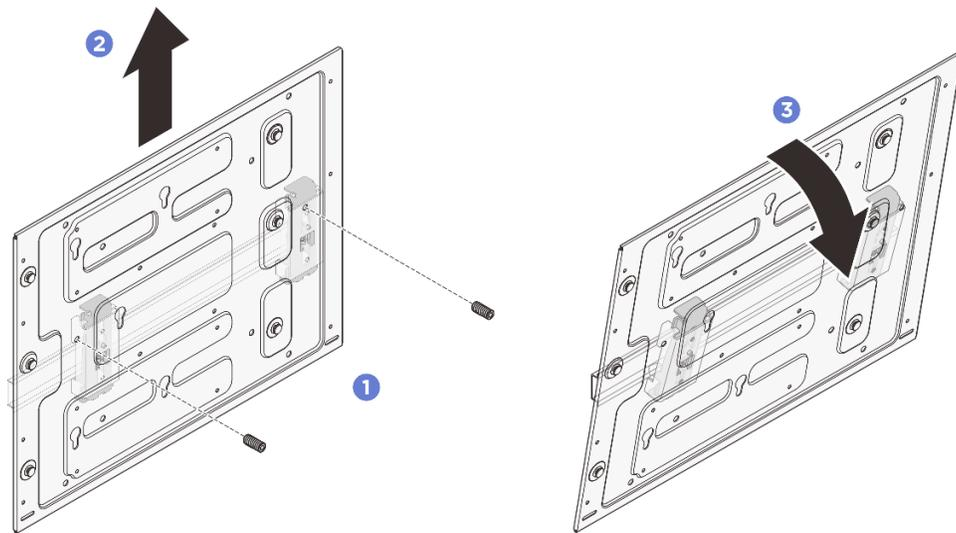
图 43. 卸下 DIN 导轨安装板
