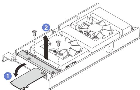
图 81. 卸下风扇桥接线缆盖
