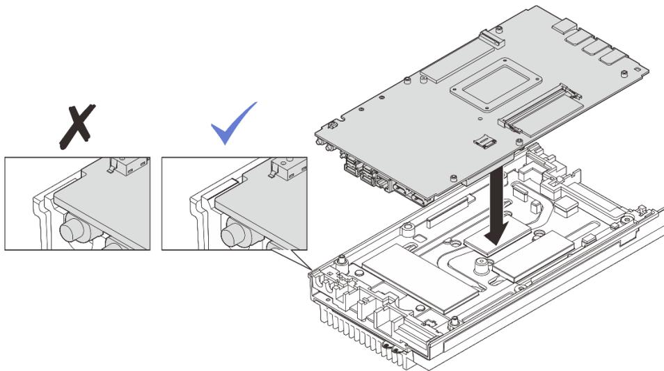
图 144. 安装主板
