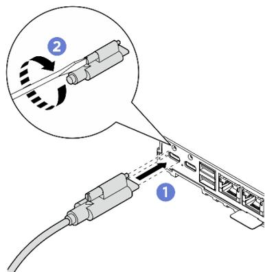
图 59. 安装电源线
