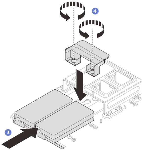
图 66. 安装电源适配器
