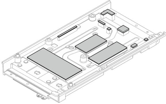
图 140. 顶盖导热垫
