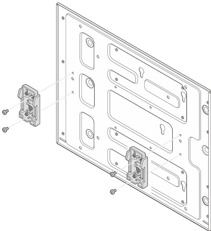
图 48. 安装 DIN 导轨夹
