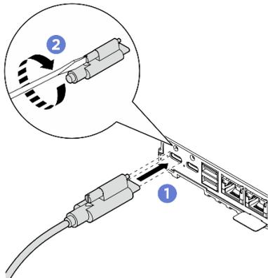
图 67. 连接电源线
