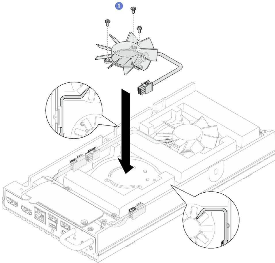
图 100. 安装风扇模块
