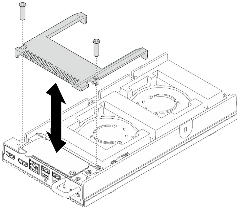
图 95. 安装风扇护罩
