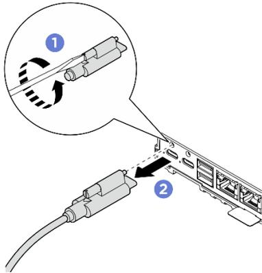
图 69. 拔下电源线
