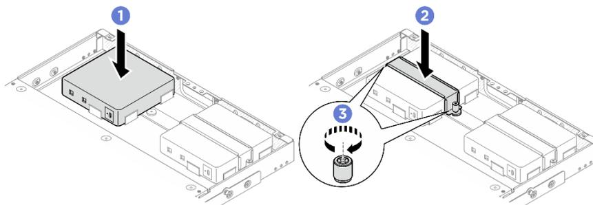
图 71. 安装电源适配器
