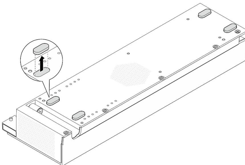
图 55. 从 PCIe 扩展套件上卸下橡胶脚垫
