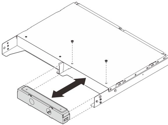
图 8. 安装节点填充件
