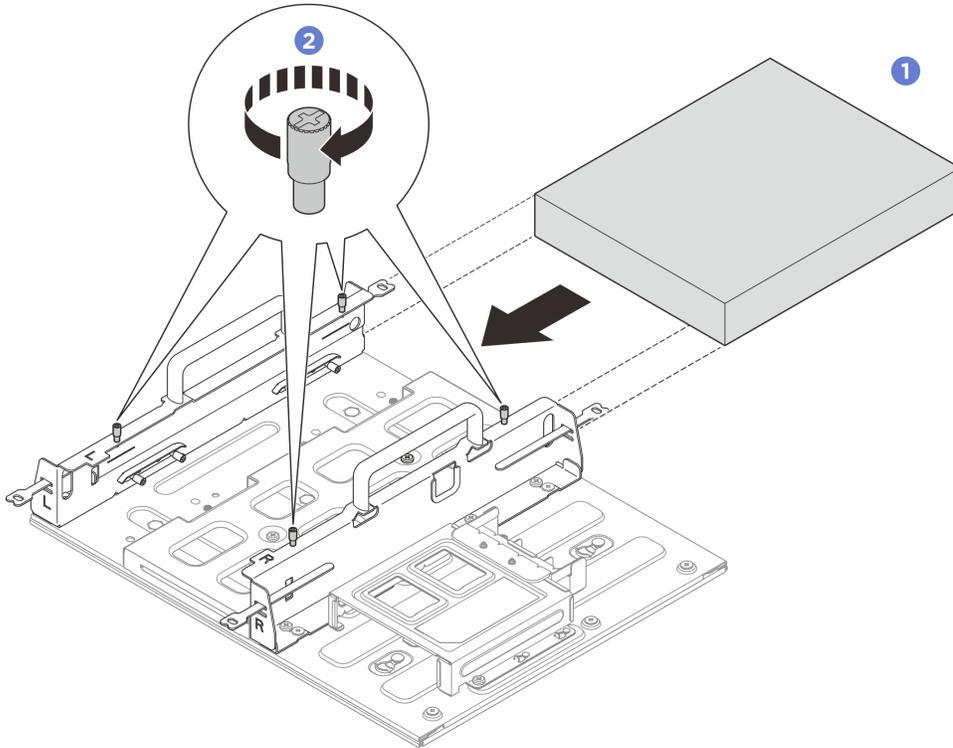
图 53. 将节点安装在节点套筒中
