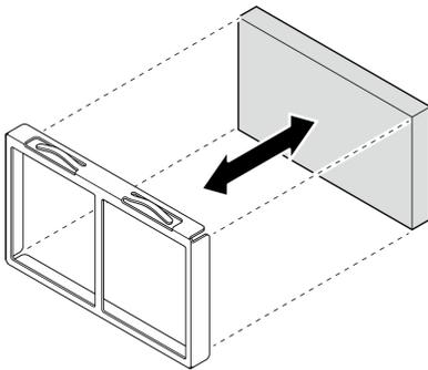
图 159. 卸下灰尘过滤器
