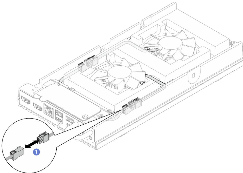
图 96. 拔下风扇桥接线缆
