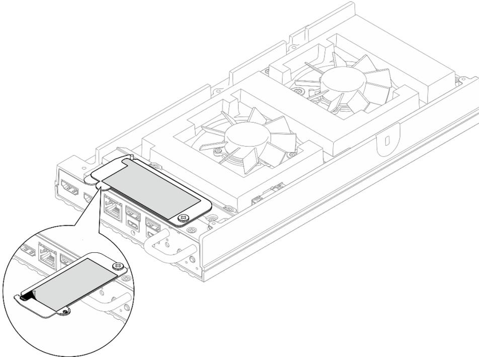
图 153. 抽取式信息卡上的 Lenovo XClarity Controller 网络访问标签
