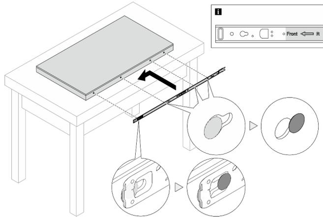
图 10. 将内侧导轨安装到服务器上
