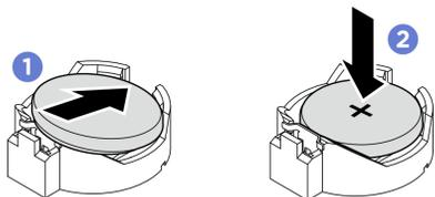
图 77. 安装 CMOS 电池
