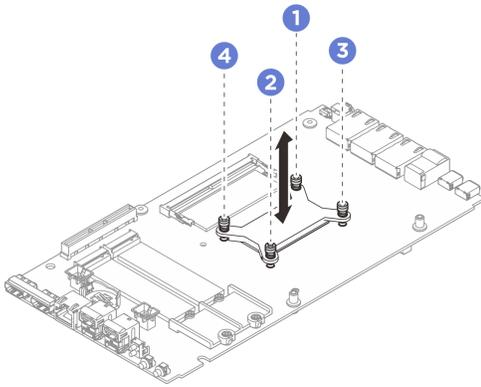
图 139. 卸下处理器散热器
