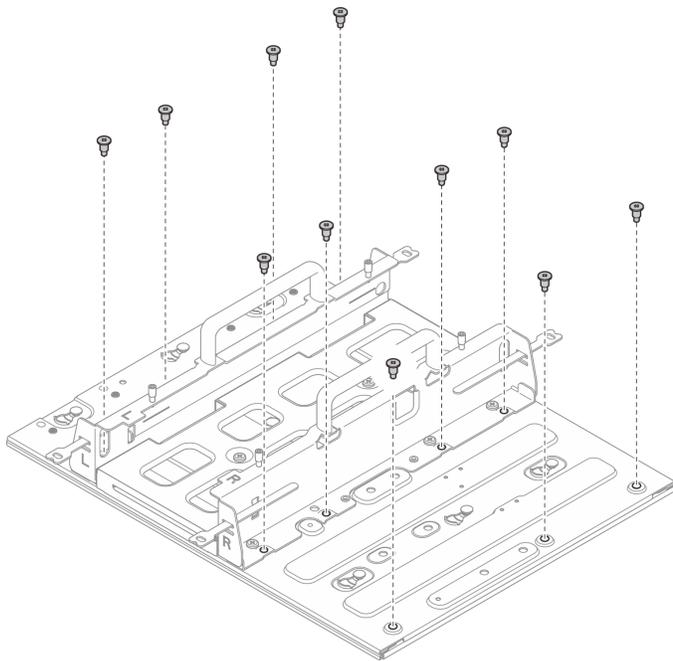
图 37. 安装不带扩展套件的节点套筒
