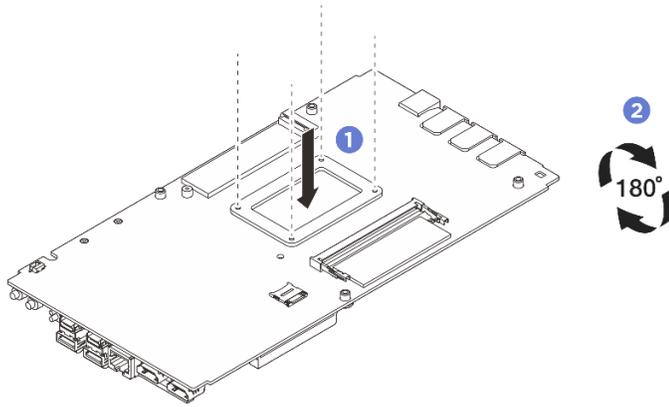
图 142. 安装处理器底板
