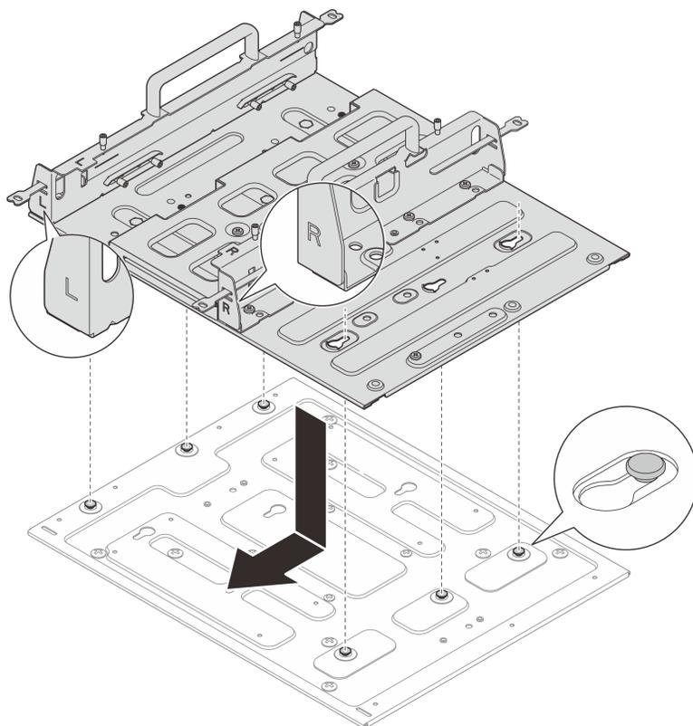
图 35. 安装节点套筒
