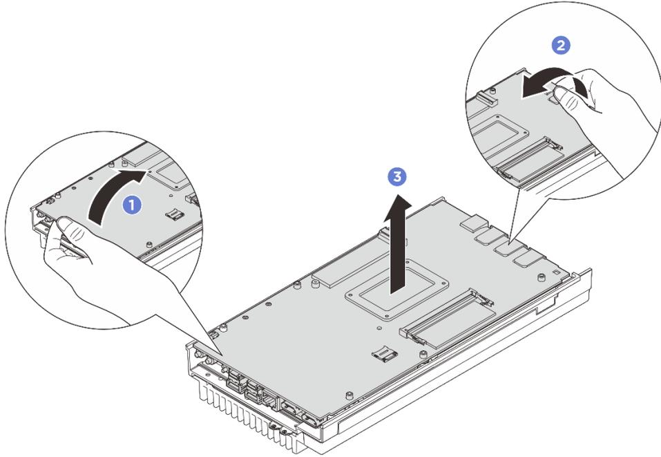
图 138. 拆卸主板
