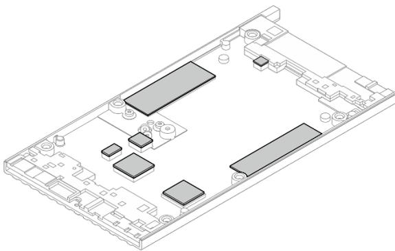
图 152. 底盖导热垫
