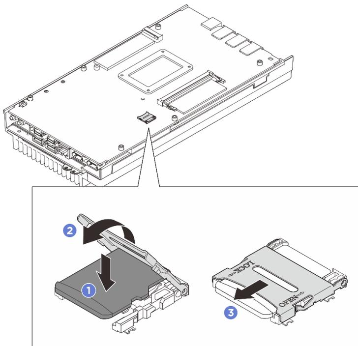
图 123. 安装 MicroSD 卡
