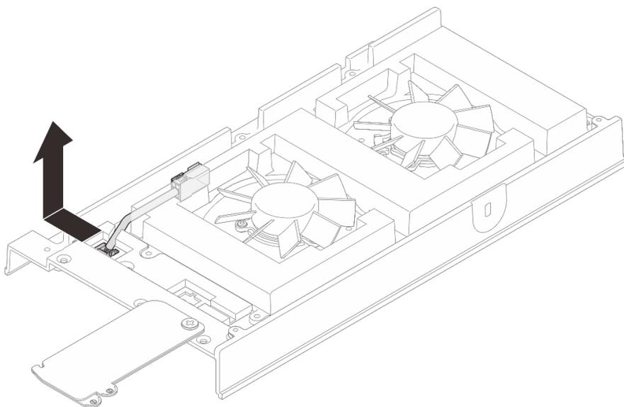
图 83. 卸下风扇桥接线缆
