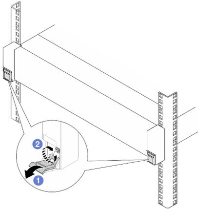
图 14. 将服务器固定到机架正面
