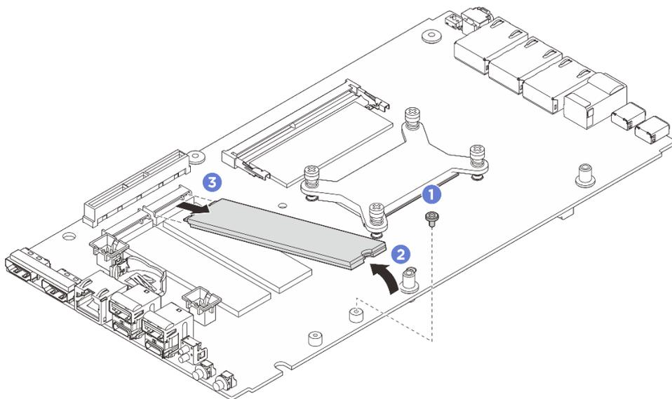
图 106. 卸下 M.2 硬盘 (22110 外形规格)
