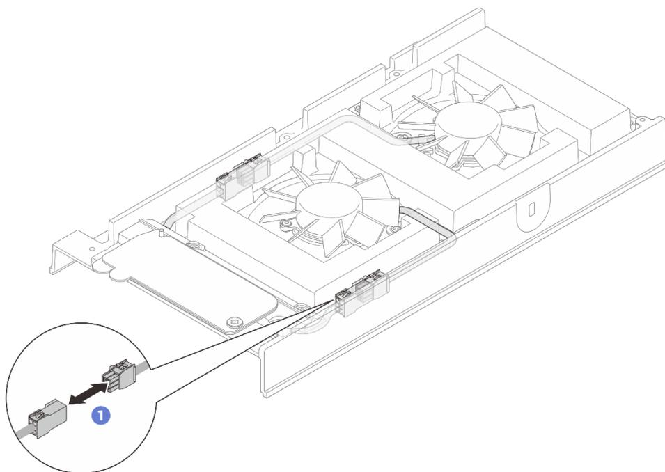
图 82. 拔下风扇桥接线缆
