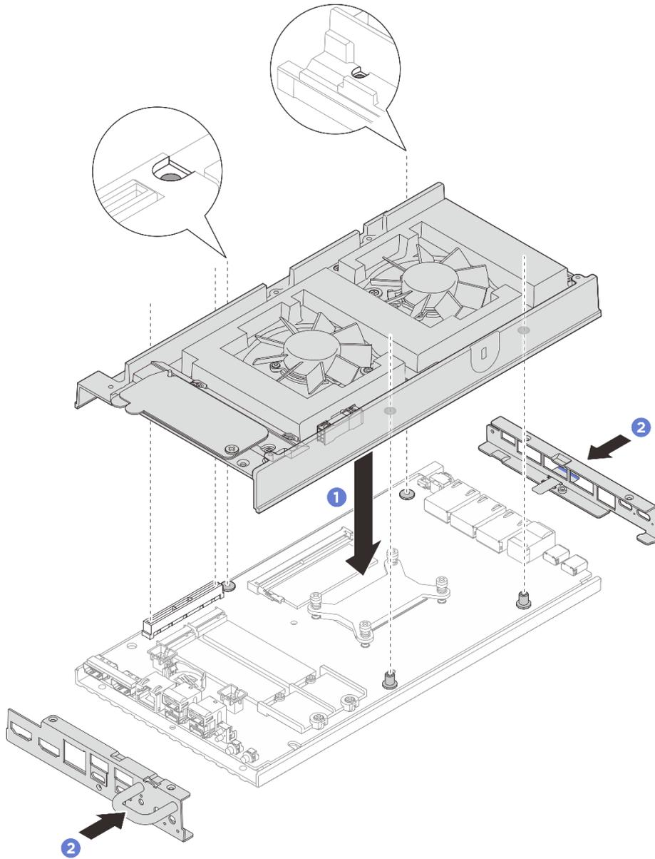
图 128. 安装顶盖
