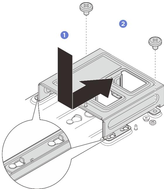
图 64. 安装电源适配器支架
