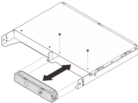
图 18. 安装节点填充件
