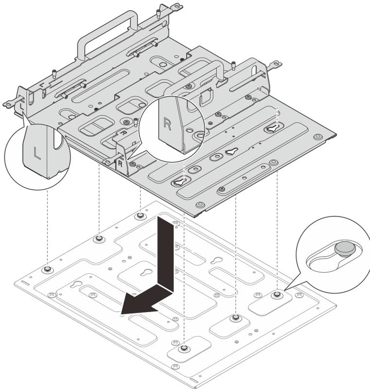
图 50. 安装节点套筒
