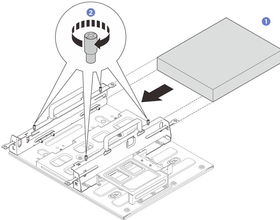
图 38. 将节点安装在节点套筒中
