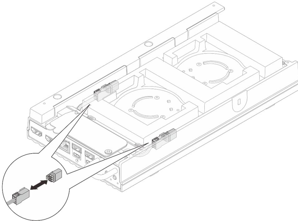
图 92. 卸下风扇桥接线缆防尘塞
