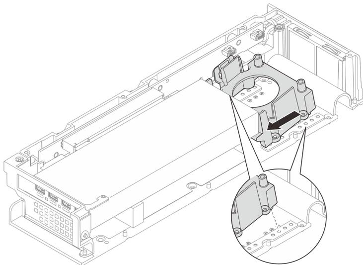
图 173. 安装支撑罩
