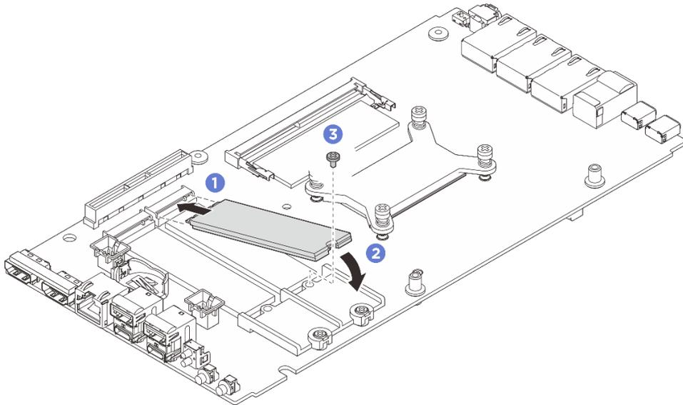
图 115. 安装 2280 规格 M.2 硬盘
