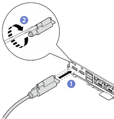
图 72. 安装电源线
