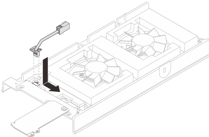
图 84. 安装风扇桥接线缆
