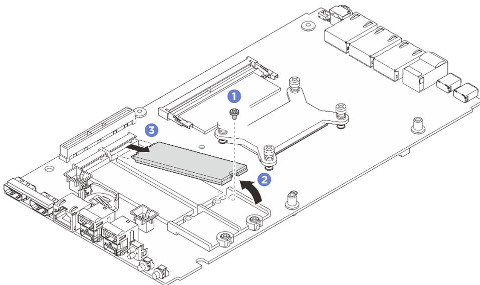
图 107. 卸下 M.2 硬盘 (2280 外形规格)
