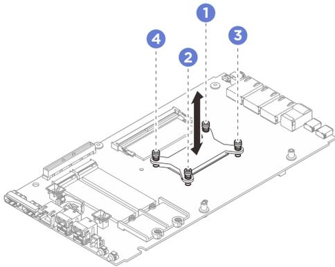
图 143. 安装处理器散热器
