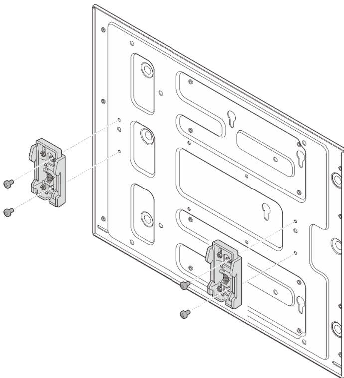
图 44. 卸下 DIN 导轨夹
