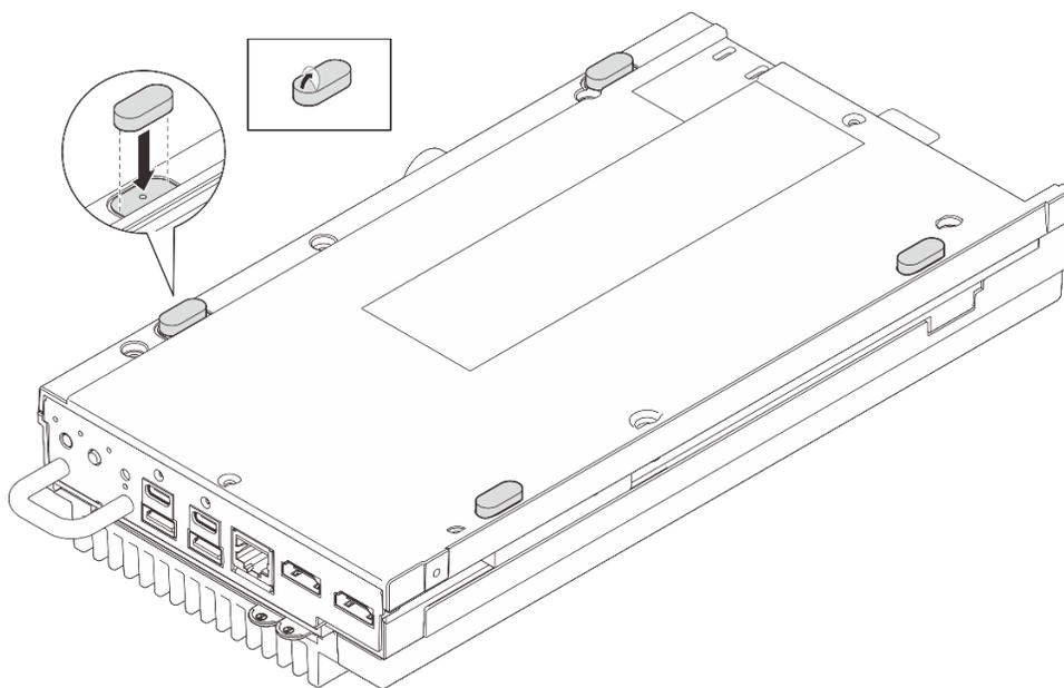
图 56. 将橡胶脚垫安装到节点上
