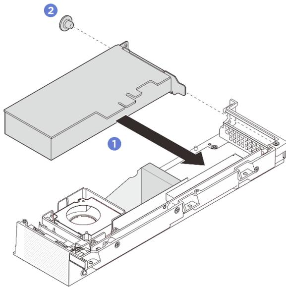
图 178. 安装 PCIe 适配器
