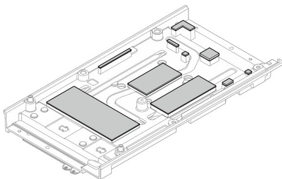
图 127. 顶盖导热垫
