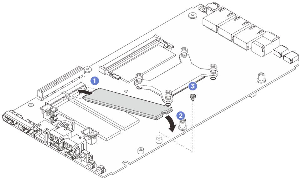
图 113. 安装 22110 规格 M.2 硬盘
