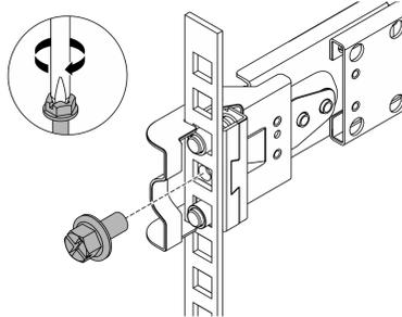
图 15. 将服务器固定到机架背面
