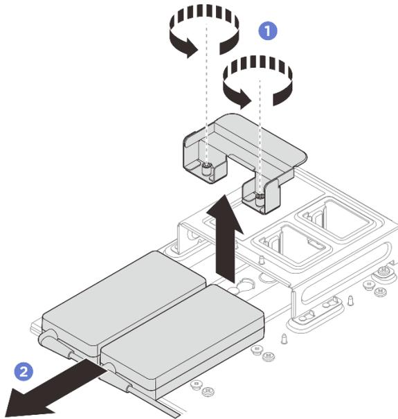
图 62. 卸下电源适配器
