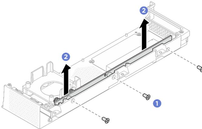
图 175. 卸下 PCIe 转接卡
