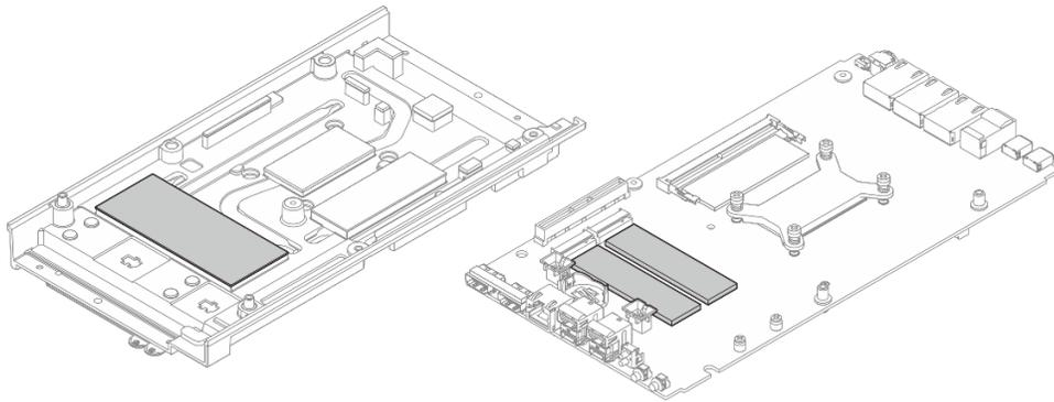
步骤 2. 服务器在插槽 2 和插槽 3 上支持两种类型的 M.2 硬盘。外形规格 22110 和 2280。根据 M.2 外形规格的不同，安装过程会有所不同。
