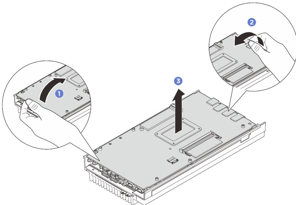
图 150. 拆卸主板
