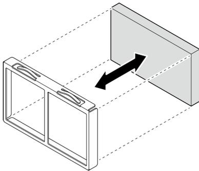
图 160. 安装灰尘过滤器
