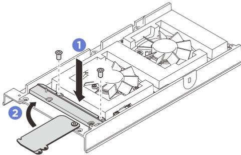
图 87. 安装风扇桥接线缆盖
