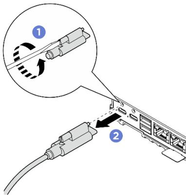
图 58. 拔下电源适配器
