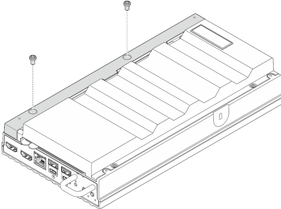
图 80. 安装螺钉
