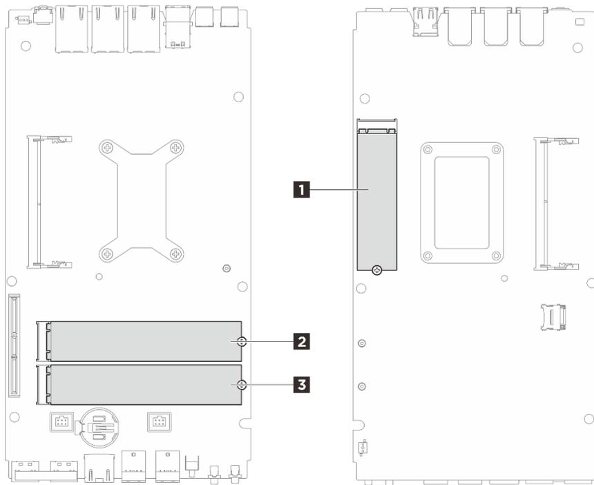
图 104. M.2 硬盘插槽编号
