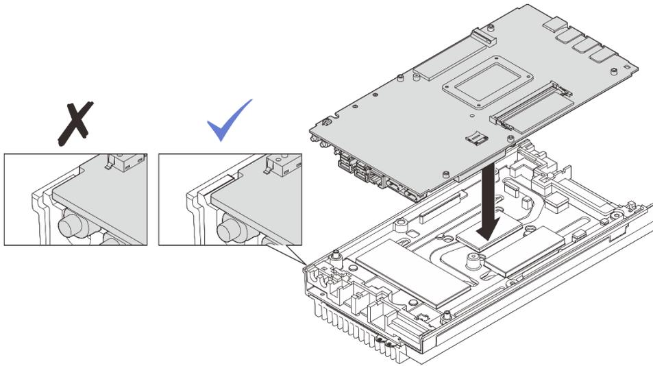
图 154. 安装主板
