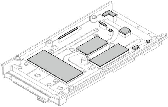
图 151. 顶盖导热垫
