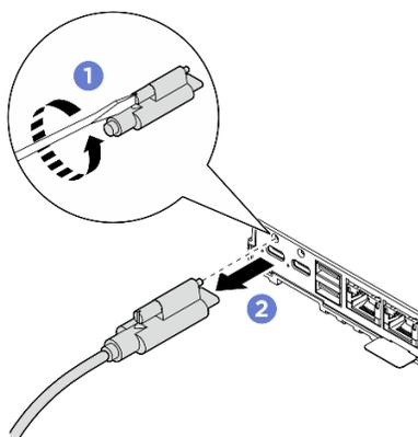
图 60. 拔下电源线
