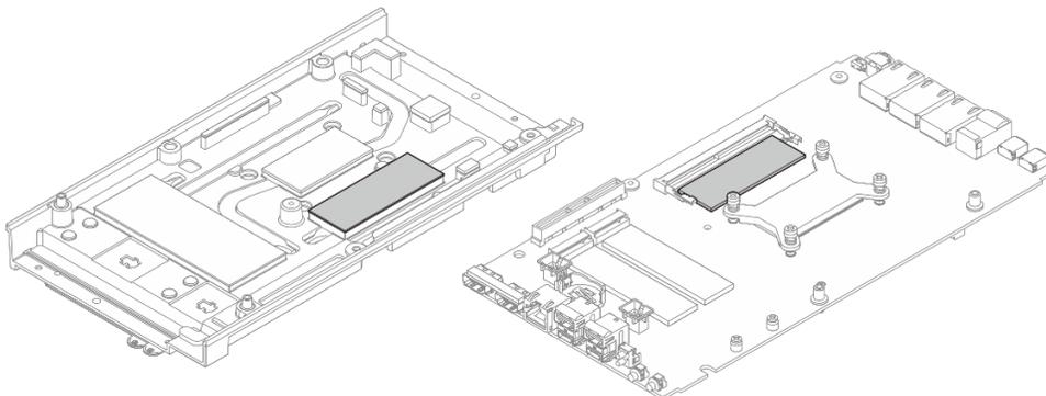
图 120. 内存条插槽 2 导热垫 (底盖侧和主板侧)
