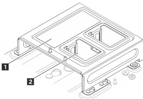
图 61. 电源适配器插槽编号
