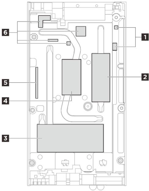
图 2. 顶盖 — 导热垫套件的标识和位置
