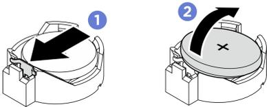
图 75. 卸下 CMOS 电池
