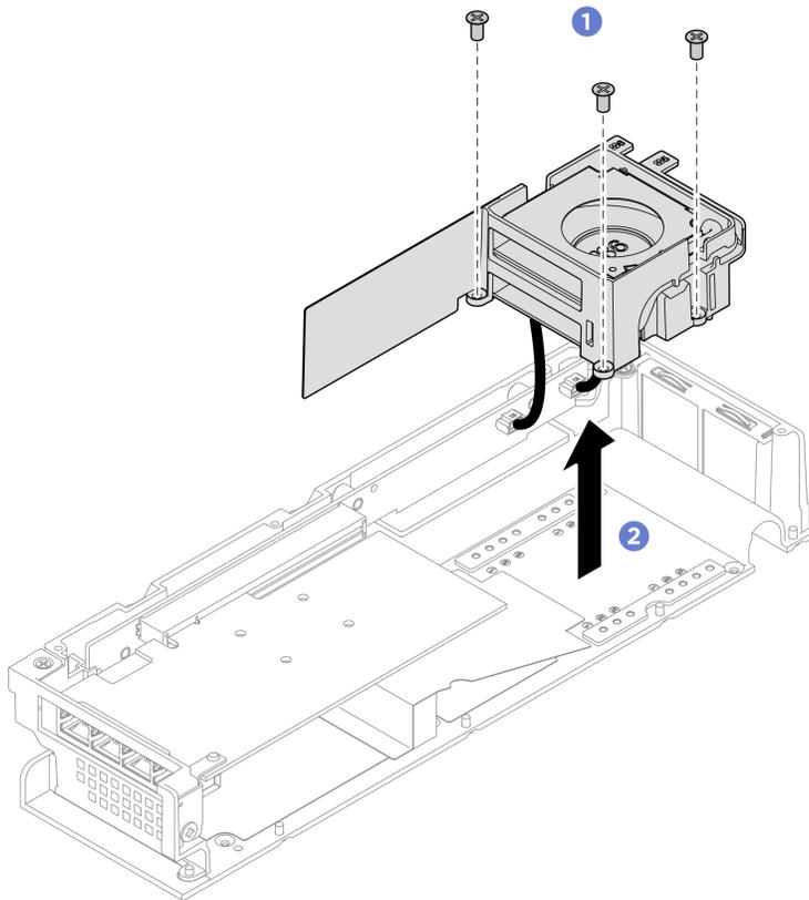
步骤 3. 从 PCIe 转接卡上拔下所有风扇电源线。
