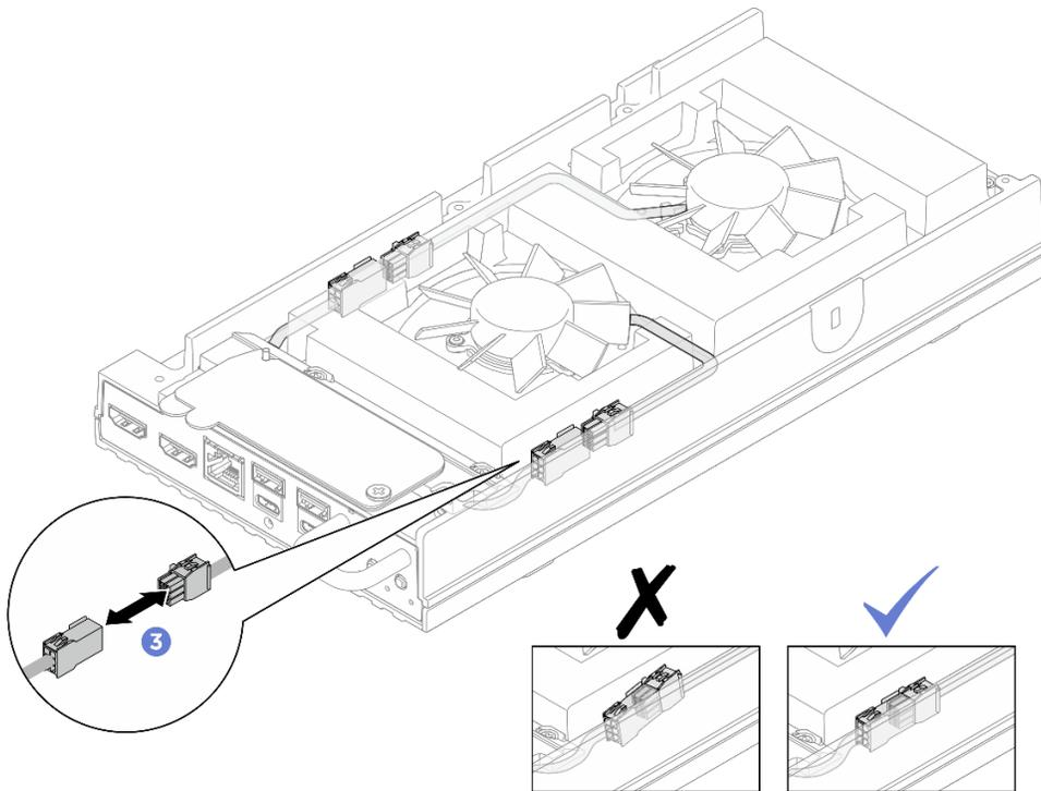
图 103. 连接风扇桥接线缆
