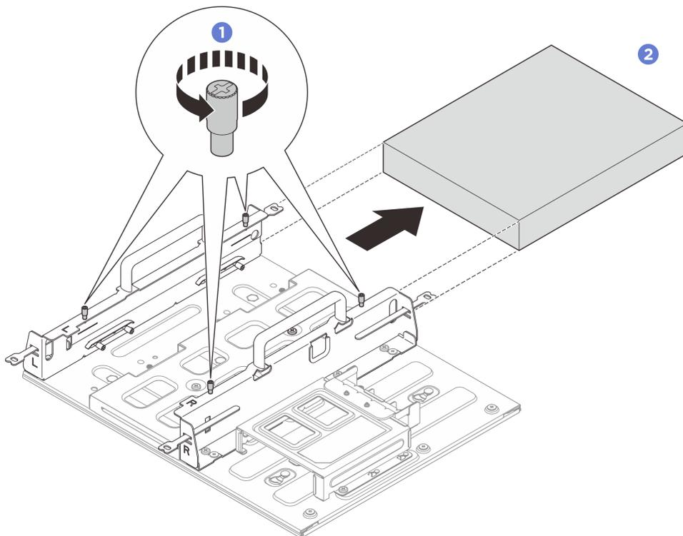
图 39. 从节点套筒中卸下节点
