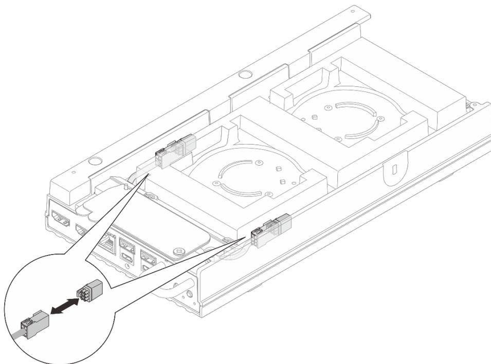
图 91. 卸下风扇桥接线缆防尘塞
