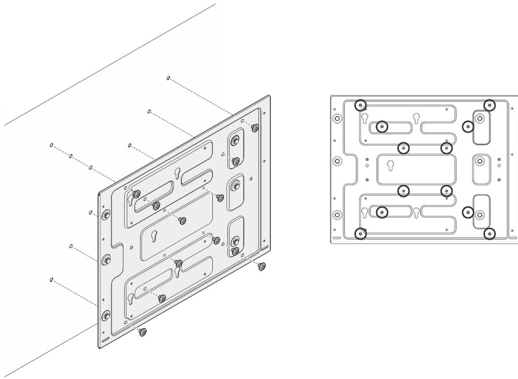
图 32. 安装壁挂板
