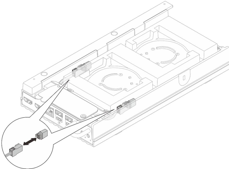
图 94. 安装风扇桥接线缆防尘塞
