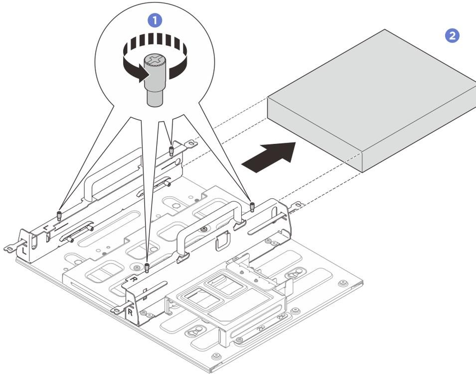
图 21. 从节点套筒中卸下节点
