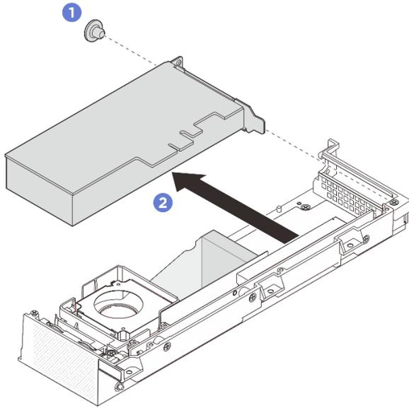
图 177. 卸下 PCIe 适配器
