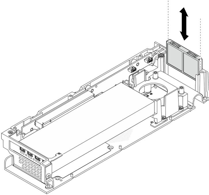
图 158. 卸下灰尘过滤器夹持器
