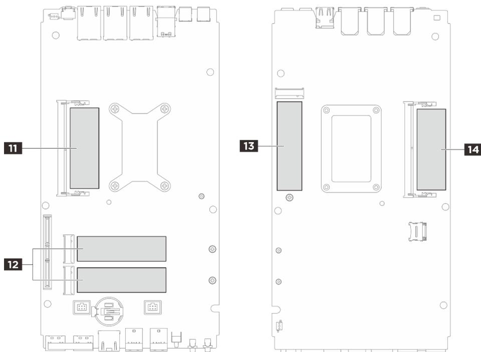
图 4. 主板 — 导热垫套件的标识和位置
