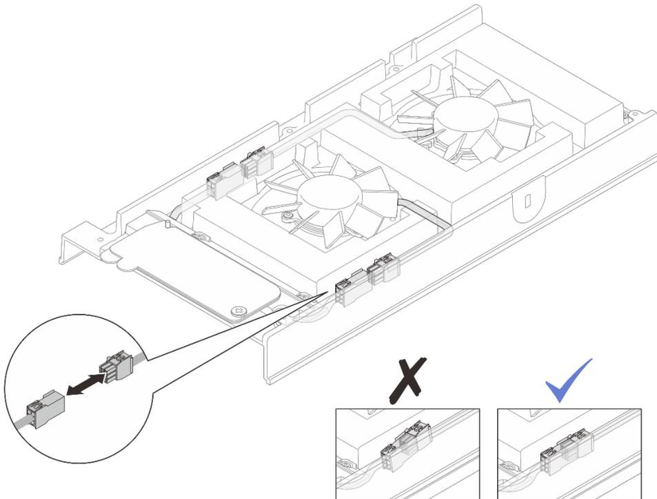
图 88. 重新连接风扇桥接线缆
