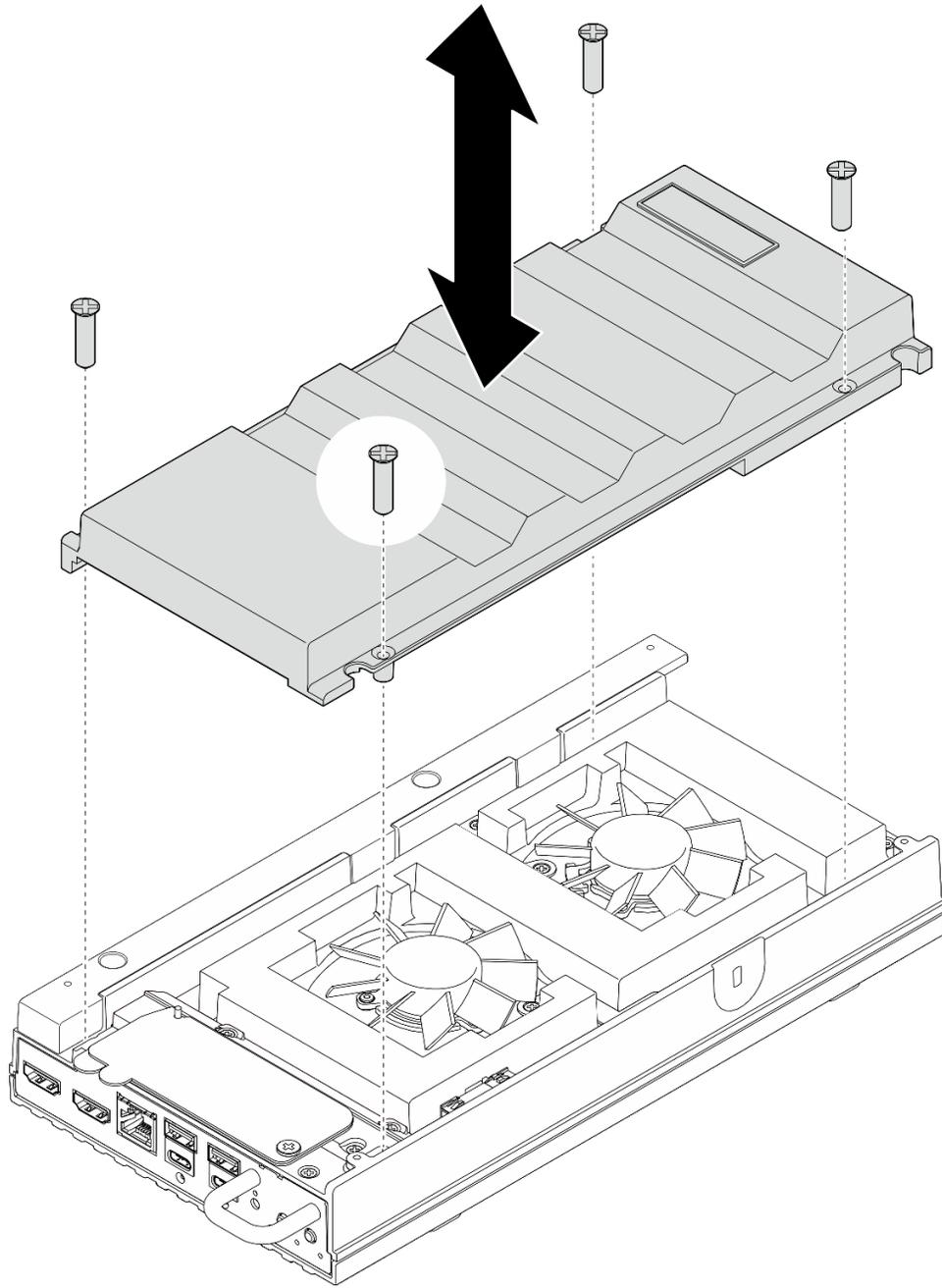
图 93. 安装风扇护罩
