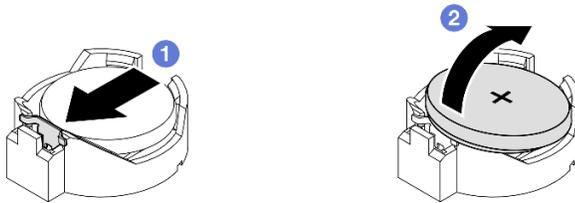
Figura 76. Extracción de una batería CMOS
