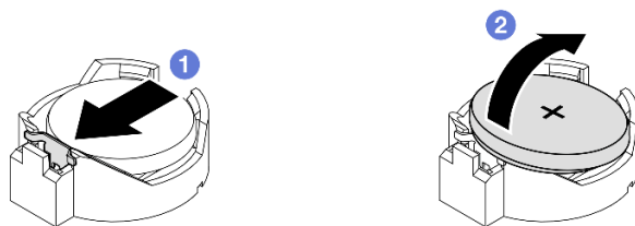
Figura 57. Rimozione di una batteria CMOS
