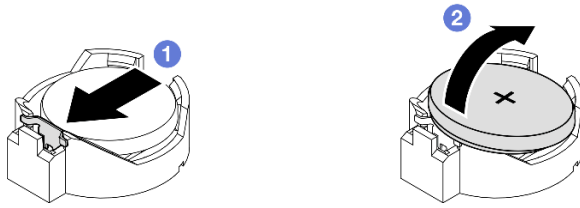
Figura 76. Rimozione di una batteria CMOS
