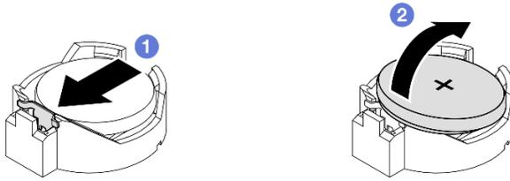
Figura 76. Rimozione di una batteria CMOS
