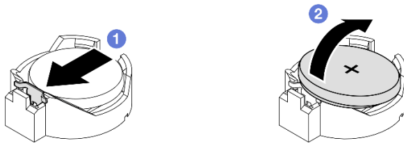
図 57. CMOS バッテリーの取り外し
