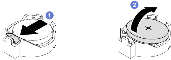
그림 76. CMOS 배터리 제거
